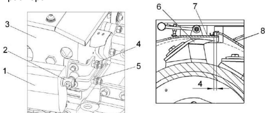
1 – электромеханизм; 2 – шток электромеханизма; 3 – корпус заточного устройства; 4, 5 – втулки; 6 – нож; 7 – крышка; 8 – рама барабана
