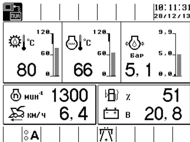
Рисунок 1.31 – Экран транспортирования
