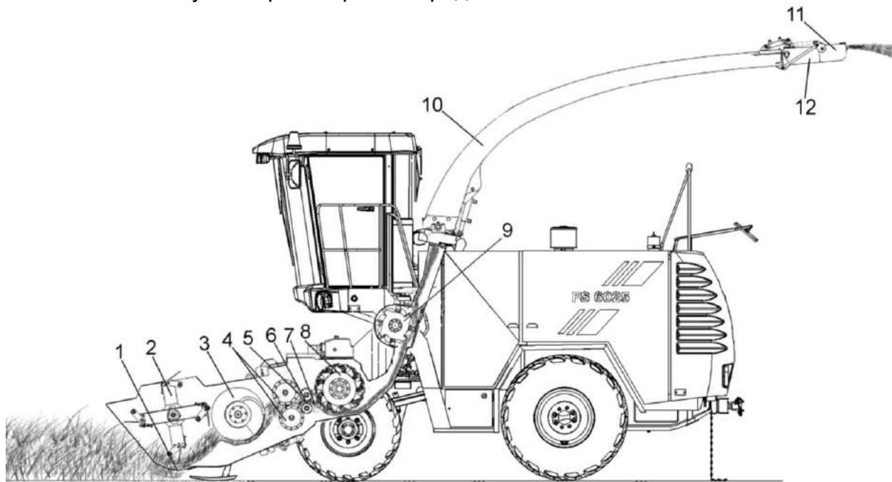
1 – режущий аппарат; 2 – мотовило; 3 – шнек; 4 – вальцы передние; 5 – валец подпрессовывающий; 6 – валец гладкий; 7 – бруск противорежущий; 8 – барабан измельчающий; 9 – ускоритель выброса; 10 – силосопровод; 11, 12 – козырьки
