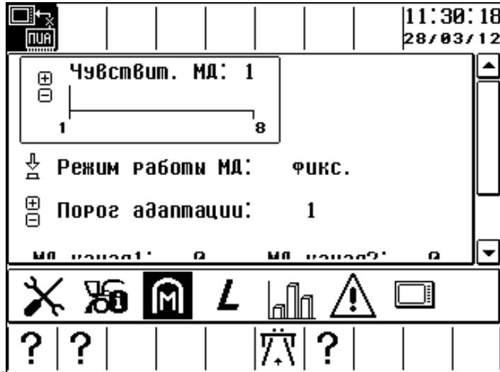
Рисунок 2.20– Установки металлодетектора
