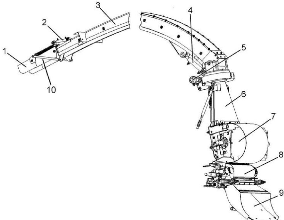
1, 10 - козырьки; 2, 4 – гидроцилиндры; 3 – силосопровод; 5 – гидромотор поворота силосопровода; 6 – основание силосопровода; 7 – ускоритель выброса; 8 – активный доизмельчитель зерен кукурузы (опция); 9 – камера приемная
