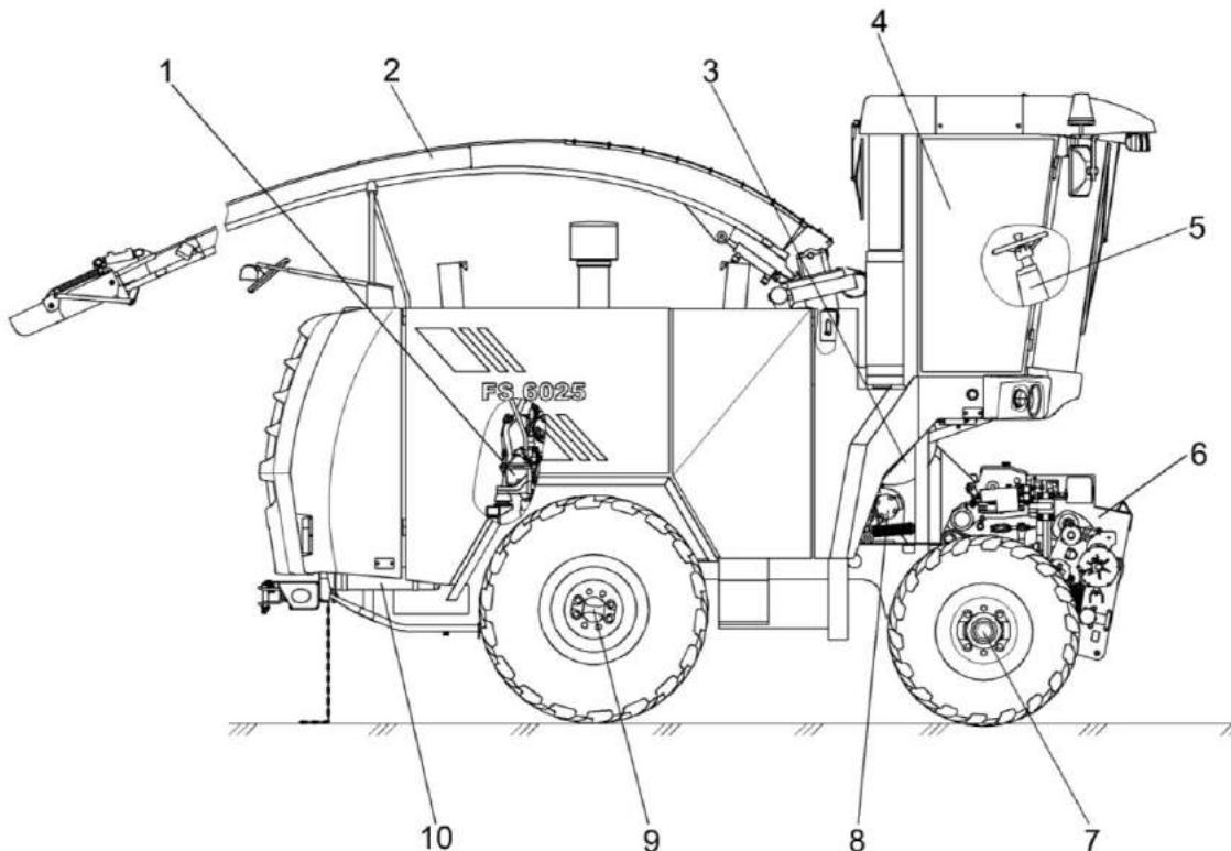
1 – моторная установка; 2 – силосопровод; 3 – ускоритель выброса; 4 – кабина; 5 – элементы управления; 6 – питающе-измельчающий аппарат; 7 – мост управляемых колес; 8 – доизмельчающее устройство; 9 – мост ведущих колес; 10 – пневмосистема
