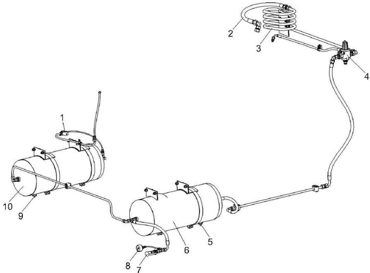
1 – клапан электромагнитный; 2 – рукав; 3 – трубопровод; 4 – регулятор давления; 5, 9 – клапаны слива конденсата; 6, 10 - ресиверы; 7 – пневмовывод; 8 – манометр
