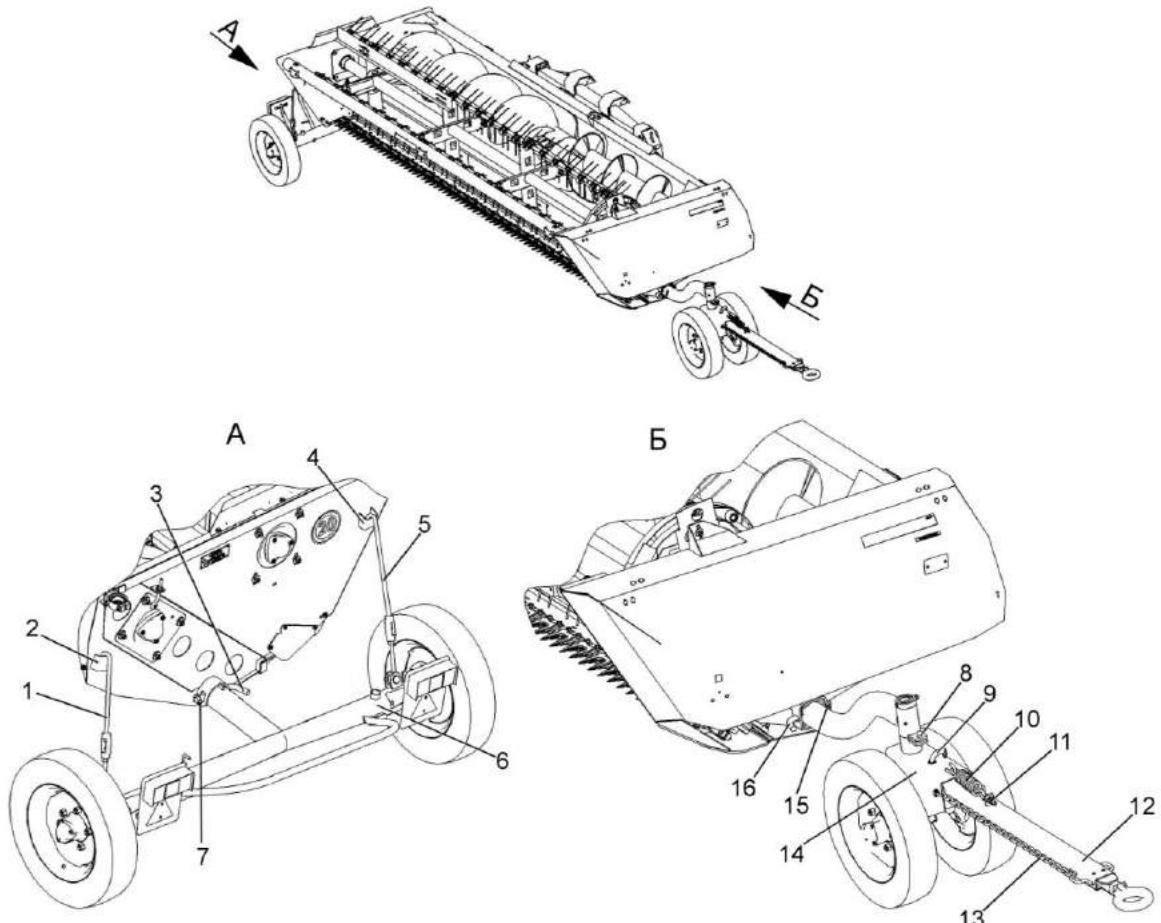
1, 5 – стяжки; 2, 4 – ухо; 3, 9, 14, 16 – фиксатор; 6 - тележка задняя; 7 – фиксатор со стопорным кольцом; 8 – кронштейн; 10 – пружина; 11 – гайка зацепа; 12 – дышло; 13 – тележка передняя; 15 – стопорное кольцо
