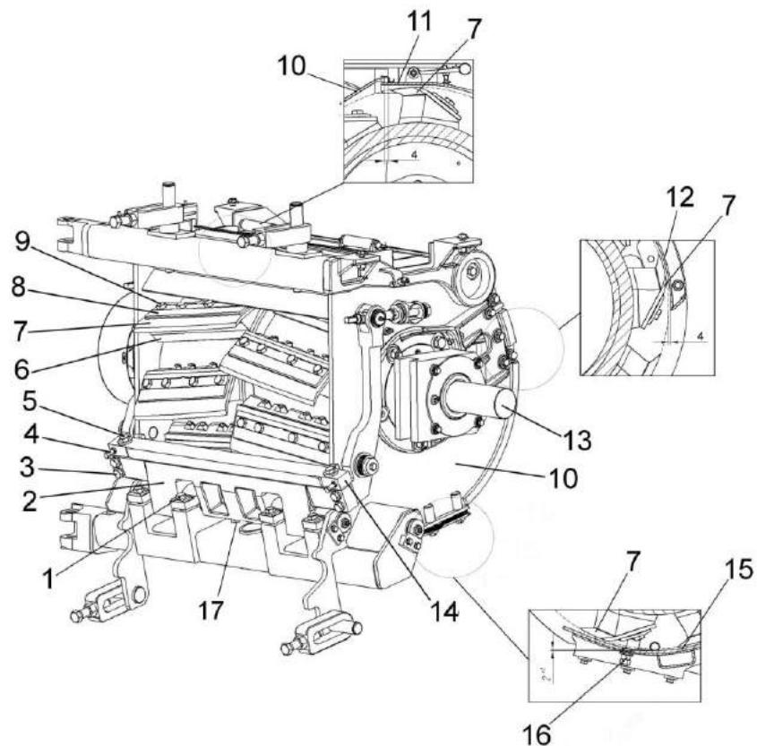
1, 3, 4, 5, 9, 16, 17 – болты; 2 – подбрусник; 6 – опора ножа; 7 – нож; 8 – прижим ножа; 10 – рама барабана; 11 – крышка; 12 – крыша; 13 – барабан измельчающий; 14 - противо-режущий брус; 15 – поддон
