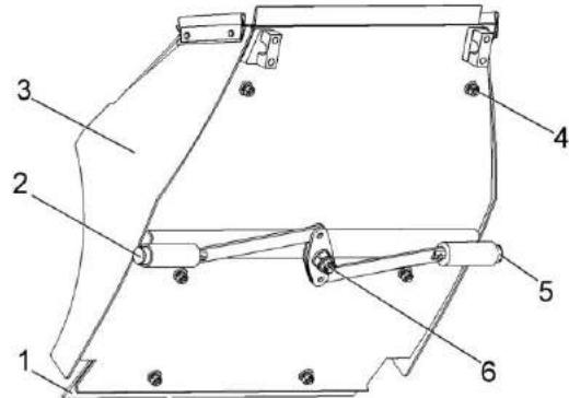
1 – лист сменный; 2, 5 - фиксаторы; 3 – камера приемная; 4 – болт; 6 – втулка
