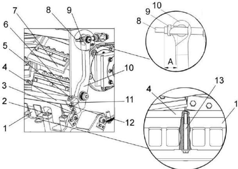
1 – опора противорежущего бруса; 2, 3, 5, 6, 12, 13 – болты; 4 – противорежущий брус; 7 – нож; 8 – винт; 9, 11 – гайки; 10 - рычаг
