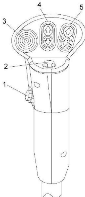
1 – кнопка ЭКСТРЕННЫЙ ОСТАНОВ; 2 – кнопка звукового сигнала; 3 – переключатель управления силосопроводом; 4 - переключатель управления навеской; 5 - переключатель ПРЯМОЙ ХОД/РЕВЕРС питающего аппарата
