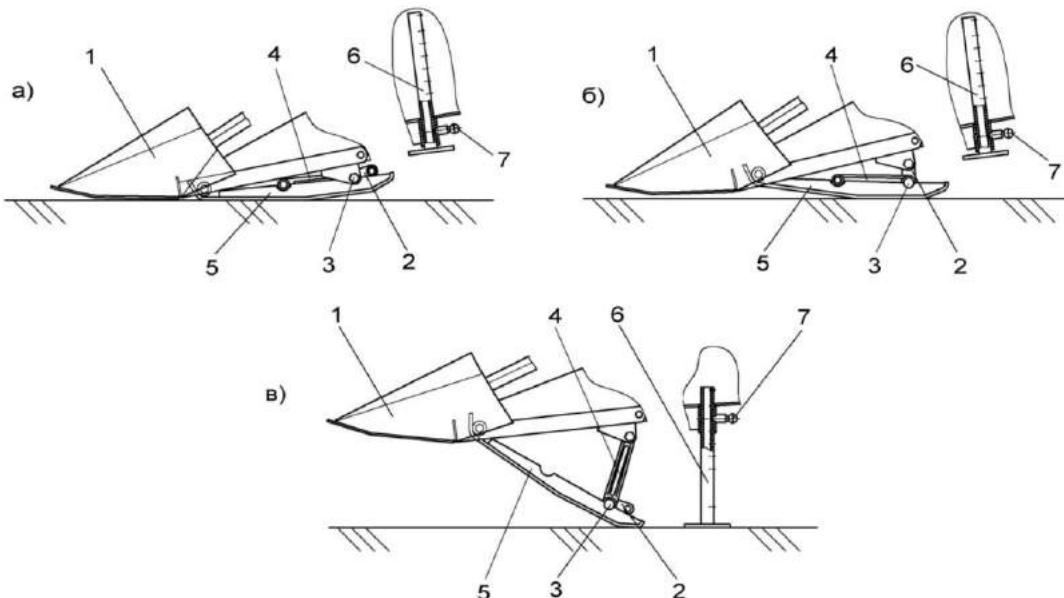
1 – носок делителя; 2, 4 – стойки; 3 – ось; 5 – башмак; 6 – стойка; 7 – фиксатор
