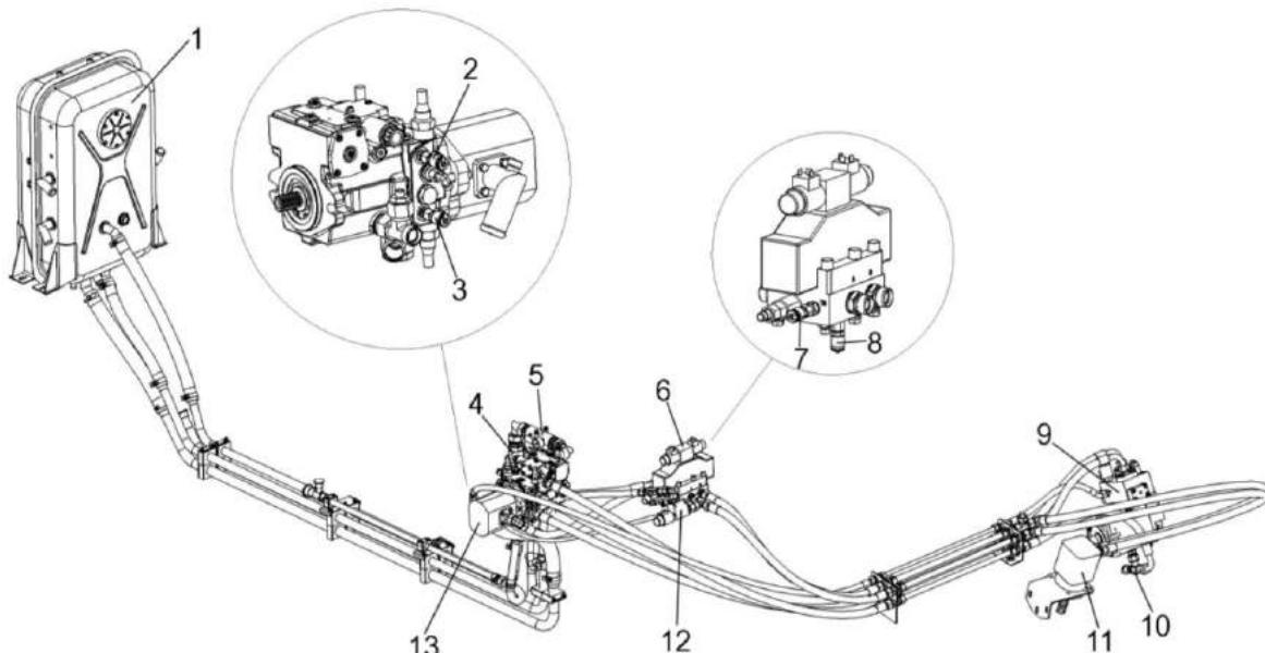
1 – бак масляный; 2, 3, 7, 8 – диагностические точки; 4 – кран; 5 – фильтр всасывающий; 6 – гидроблок; 9 – гидромотор привода питающего аппарата с гидроблоком экстренного останова; 10 – полумуфта заправочная основная; 11 - гидромотор привода адаптеров; 12 – клапан электроуправляемый; 13 – гидронасос двухсекционный (аксиально-поршневой привода питающего аппарата и шестерennый привода адаптеров)
