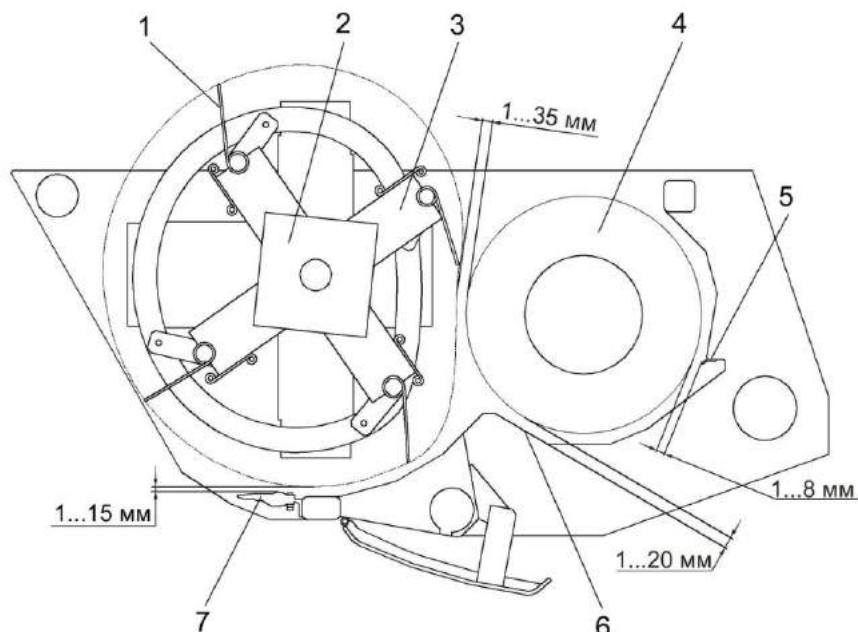
1 – зуб пружинный; 2 – опора мотовила; 3 – мотовило; 4 – шнек; 5 – чистик; 6 – поддон; 7 – палец режущего аппарата;
