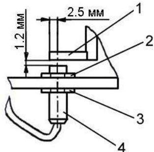
1 – брускок абразивный; 2, 3 – гайки; 4 – датчик
