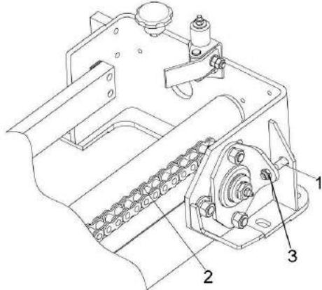
1 – болт; 2 – цепь; 3 – гайка
