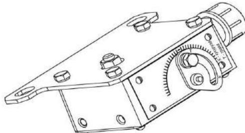
Рисунок 2.21 – Датчик камнедетектора
