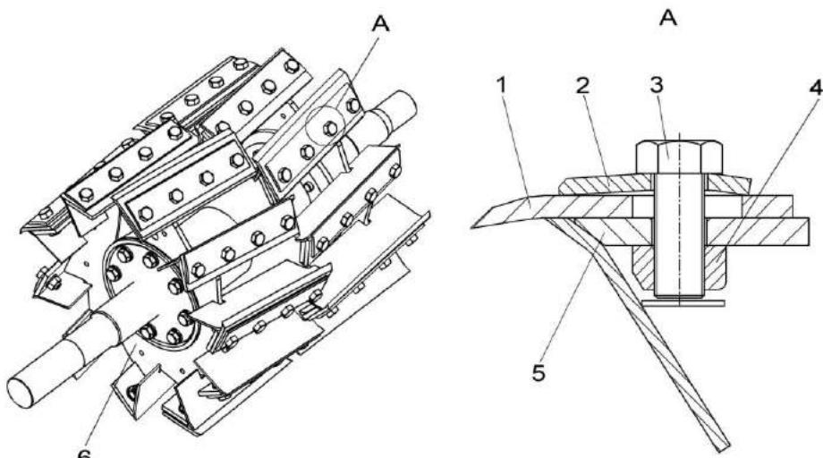
1 – нож; 2 – прижим ножа; 3 – болт; 4 – планка; 5 – опора ножа; 6 – катушка барабана
