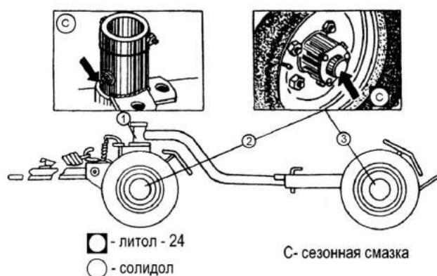
Рисунок 3.6 – Схема смазки транспортной тележки
