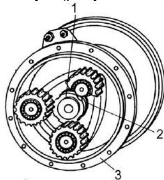
1 - гайка; 2 - шайба замочная; 3 - корпус бортового редуктора
