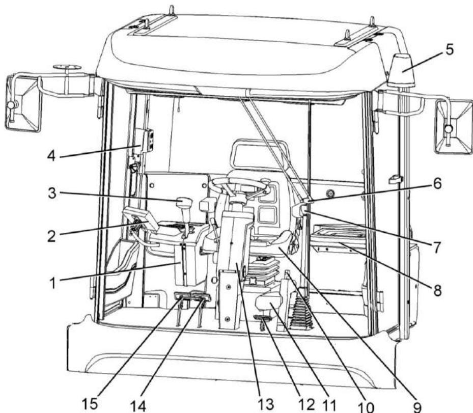
1 – пульт управления; 2 – модуль терминальный; 3 – рукоятка управления скоростью движения; 4 – панель боковая; 5 – маяк проблесковый; 6 – стеклоочиститель; 7 – рычаг переключения передач; 8 – дополнительное сиденье; 9 – сиденье оператора; 10 – стояночный тормоз; 11 – аптечка; 12 – педаль блокировки коробки передач; 13 – рулевая колонка; 14, 15 – педали управления тормозами
