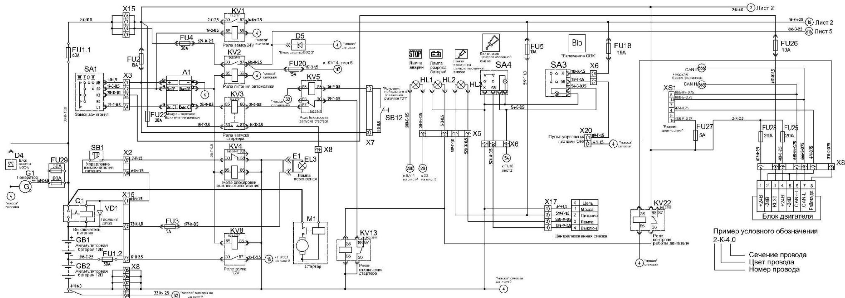
Рисунок Б.1 – Схема электрическая принципиальная комбайна (лист 1)
