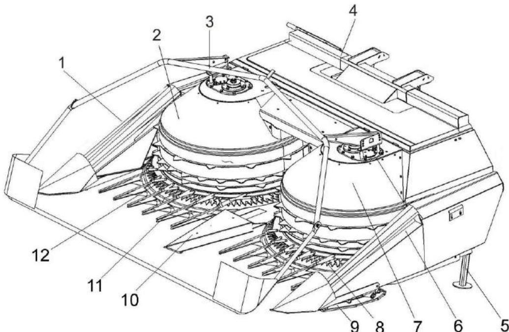
1, 6 – боковые делители; 2, 7 – барабаны; 3 – заламывающий брус; 4 – переходная рамка; 5 – стояночная опора; 8, 12 – режущие роторы; 9 – башмак; 10 – центральный делитель; 11 – гребенки
