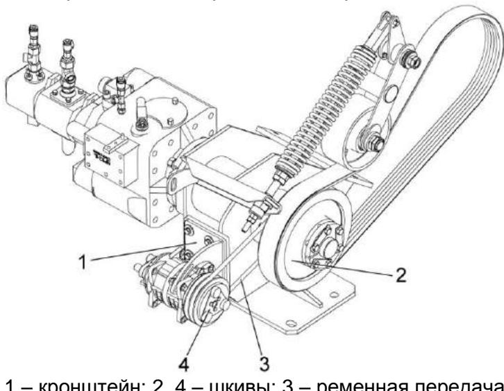
Рисунок 2.26 – Регулировка привода компрессора кондиционера
