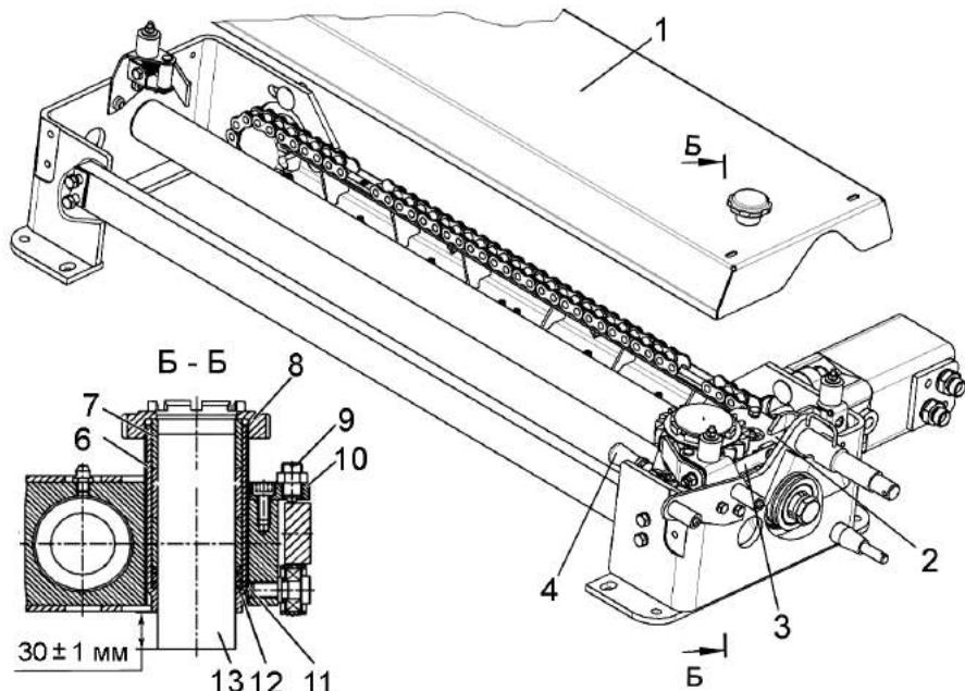
1 – крышка; 2 – каретка; 3 – прижим; 4 – фиксатор; 6 – втулка резьбовая; 7 - втулка; 8 – колесо храповое; 9 – устройство стопорное; 10 – планка; 11, 12 – кольца; 13 – брускок абразивный
