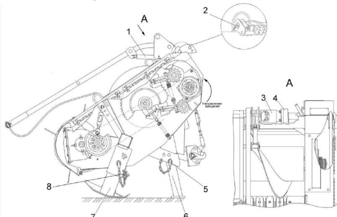
1 – гидроцилиндр; 2 – полумуфта наружная с рукавом; 3 – гидромотор; 4 – корпус;
