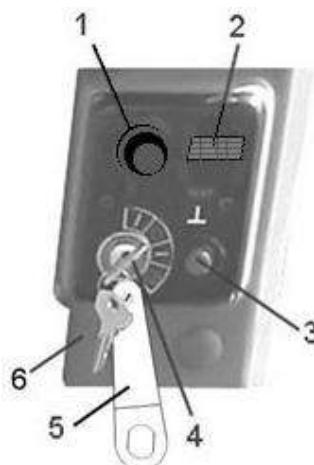
1 – прикуриватель; 2 – разъем диагностики двигателя; 3 – выключатель кнопочный выключения питания; 4 – замок зажигания; 5 – ключ специальный; 6 – стойка кабины
