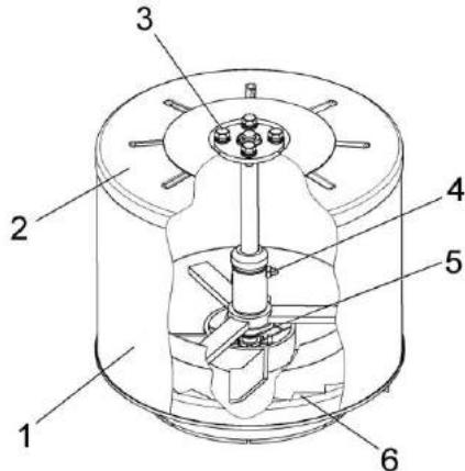
1 – сетка; 2 – крышка; 3 – болт; 4 – масленка; 5 - подшипник; 6 – крыльчатка
