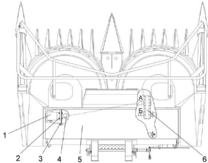
1 – гидромотор; 2 – болт; 3 – кронштейн; 4 – вал карданный; 5 – крышка; 6 – редуктор цилиндрический; А, Б – входные валы
