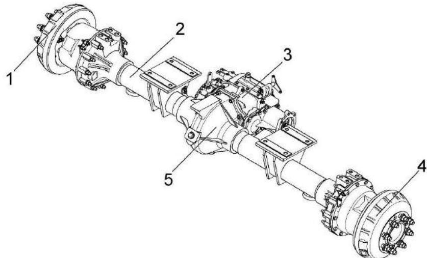
1, 4 – бортовые редуктора; 2 – кожух моста; 3 – коробка передач; 5 – дифференциал
