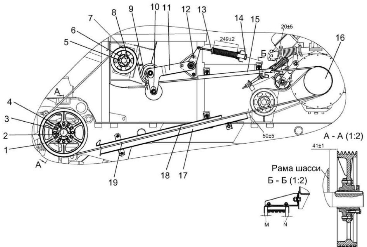
1, 7, 16 – шкивы; 2, 5 – ступицы; 3, 6 – пластины; 4, 8 – болты; 9 – ролик; 10 – ось; 11 – рычаг; 12,13 – гайка; 14 – гильза; 15, 17, 18 – щитки; 19 – ремень
