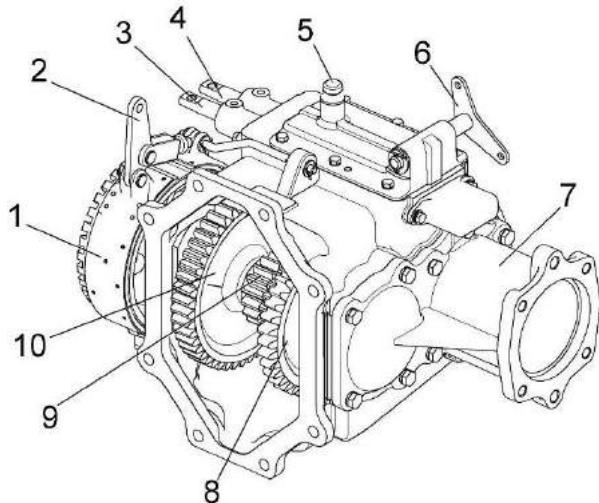
1 - тормоз стояночный; 2 – рычаг; 3 - шток переключения 2-й передачи; 4 - шток переключения 1-й и 3-й передач; 5 – сапун; 6 – рычаг механизма блокировки; 7 – стакан; 8, 9, 10 - блоки шестерен
