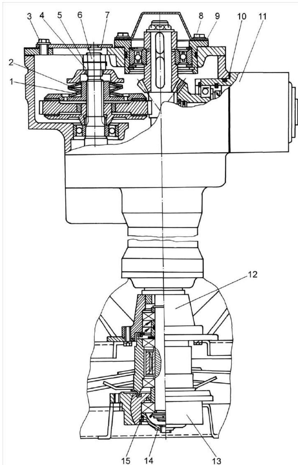
1 – нажимной диск; 2 – тарельчатая пружина; 3, 8 – болты; 4 – гайка; 5 – шайба стопорная; 6 – контргайка; 7 – крышка; 9, 10 – прокладки; 11 – корпус; 12 – фланец; 13 – опора барабана; 14 – крышка; 15 – стопорное кольцо
