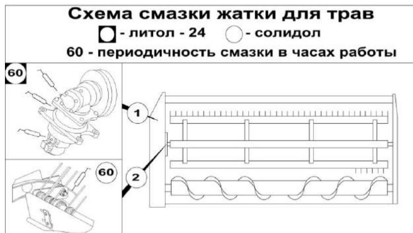
Рисунок 3.5 – Схема смазки жатки для трав
