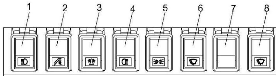
1 – выключатель габаритов; 2 – выключатель фары силосопровода; 3 – выключатель сигнального маяка; 4 – выключатель фары освещения сцепки; 5 – выключатель рабочих фар кабины; 6 – выключатель заднего стеклоочистителя (опция); 7 – выключатель переднего стеклоомывателя; 8 – выключатель переднего стеклоочистителя
