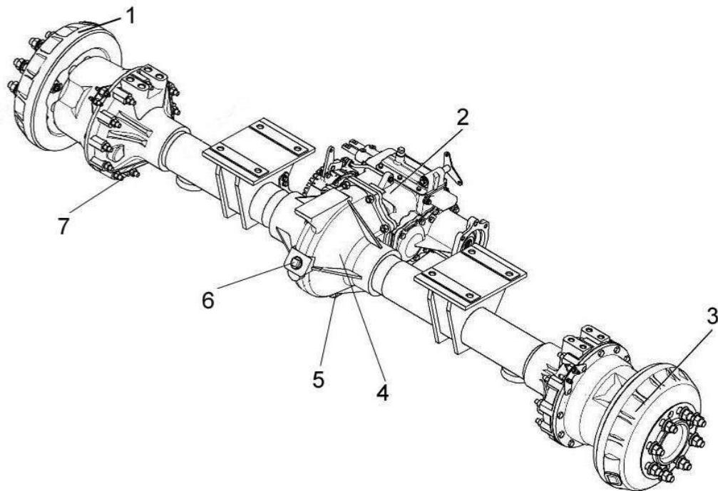
1, 3 – бортовые редуктора; 2 – коробка передач; 4 – дифференциал; 5, 7 – сливные пробки; 6 – заливная пробка
