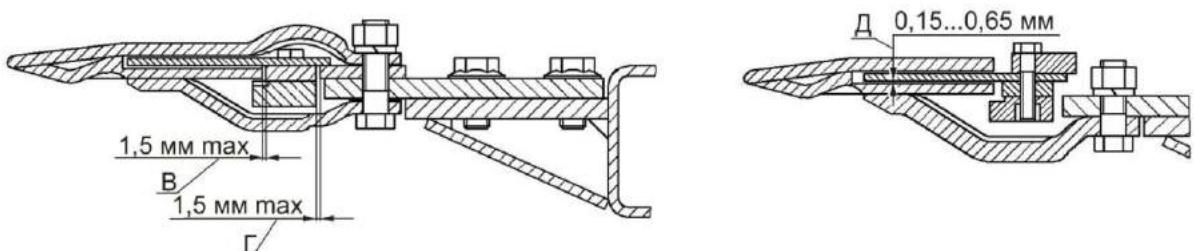
Рисунок 2.43 –Режущий аппарата жатки для трав
