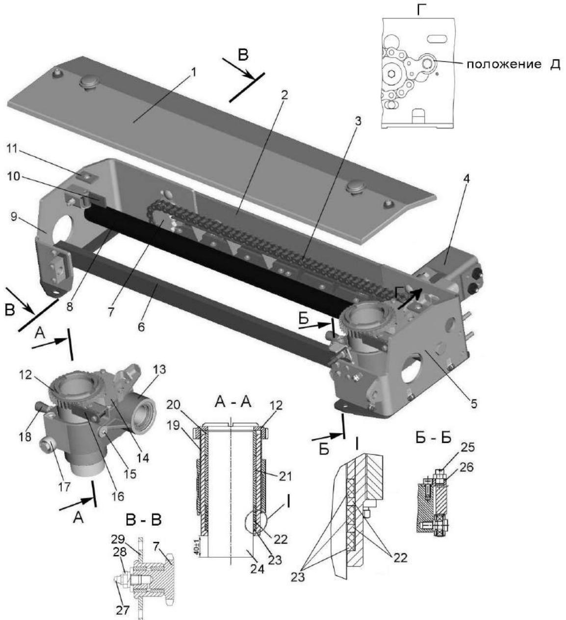
1 – крышка; 2 – ограждение; 3 - цепь; 4 – гидромотор заточного устройства; 5, 9 - кронштейны; 6, 8 – направляющие; 7 - звездочка; 10, 16 - упоры; 11 – опора; 12 - колесо храповое; 13 – каретка; 14 – прижим; 15 – масленка; 17 – ролик; 18 – фиксатор; 19 – втулка резьбовая; 20, 21 - втулки; 22 – кольца; 23 – кольца резиновые; 24 - брускок абразивный; 25 – устройство стопорное; 26 – планка; 27 – масленка; 28 – штуцер; 29 - втулка
