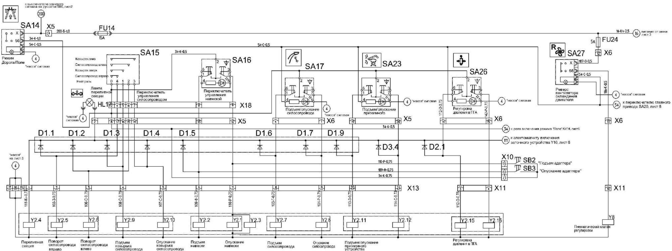
Рисунок Б.4 – Схема электрическая принципиальная комбайна (лист 4)
