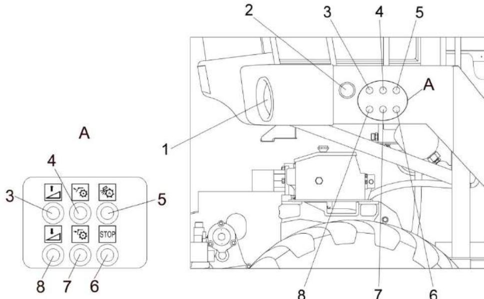
1 – фара транспортная; 2 – боковой повторитель указателя поворотов; 3 – кнопка подъема адаптеров; 4 – кнопка открытия крышки заточного устройства; 5 - кнопка включения заточного устройства; 6 – кнопка экстренного останова главного привода; 7 – кнопка закрытия крышки заточного устройства; 8 – кнопка опускания адаптеров;
