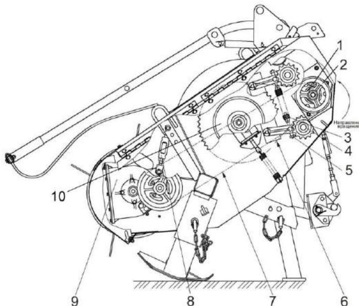
1 – звездочка; 2 – шкив; 3 – пружина; 4 – натяжная звездочка; 5 – тяга; 6 – цепная передача привода шнека; 7 – ременная передача привода подбирающего барабана; 8 – стяжка; 9 – редуктор; 10 – муфта предохранительная
