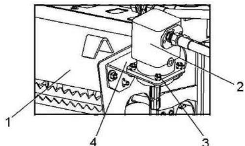
1 – питающий аппарат; 2 – гидромотор; 3 – болт;
