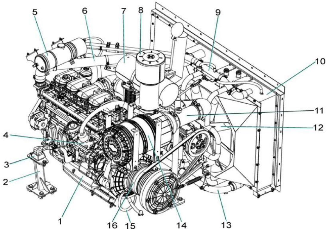
1 – двигатель; 2 – опора; 3 – амортизатор; 4 – компрессор; 5 – бачок расширительный; 6,9,13 – водяные трубы 7 – глушитель с выхлопной трубой; 8 – воздухозаборник вращающийся; 10 – радиатор; 11 – труба воздушная; 12 – вентилятор; 14 – воздушный фильтр; 15 – маслопровод сливной; 16 – главный привод.
