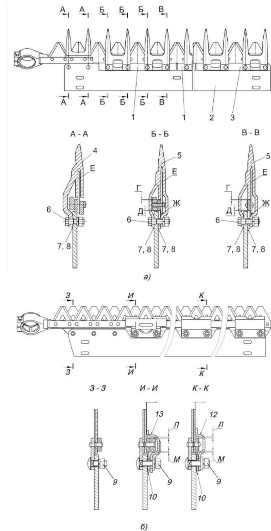
а) режущий аппарат: 1, 3 – пластины трения; 2 – брус; 4 – палец направляющий сдвоенный; 5 – палец сдвоенный; 6, 9 – гайки; 7 – регулировочная прокладка; 8 – прокладка
