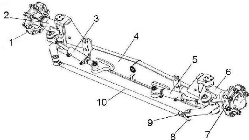
1, 7 – ступицы; 2, 6 – кулаки поворотные; 3, 5 - гидроцилиндры; 4 – балка; 8 – шарнир; 9 – гайка; 10 – тяга поперечная
