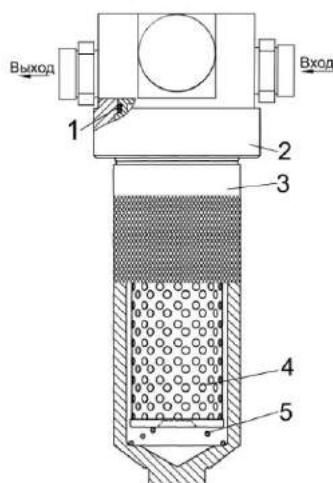
1 – кольцо уплотнительное; 2 – головка фильтра; 3 – стакан; 4 - фильтроэлемент; 5 – пружина
