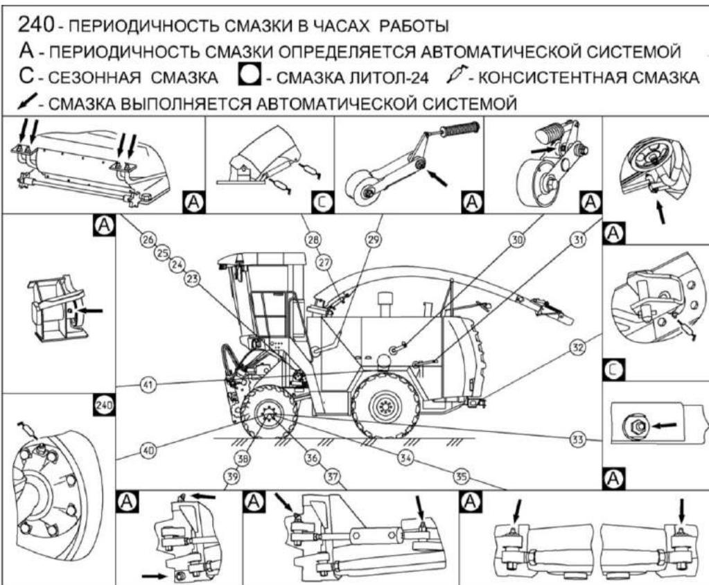
Рисунок 3.2 – Схема смазки самоходного измельчителя (вид слева)
