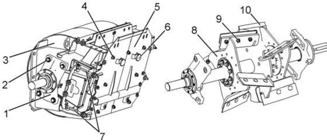
1 – корпус подшипника; 2, 4, 9 – болты; 3 – корпус ускорителя; 5 – крышка; 6 – ручка;
