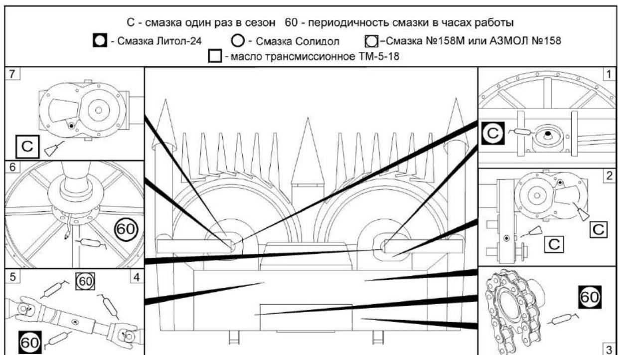
Рисунок 3.7 - Схема смазки жатки для грубостебельных культур
