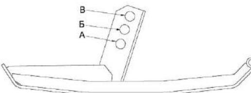
Установка башмаков на нижние отверстия соответствует более низкому срезу жатки для трав.
