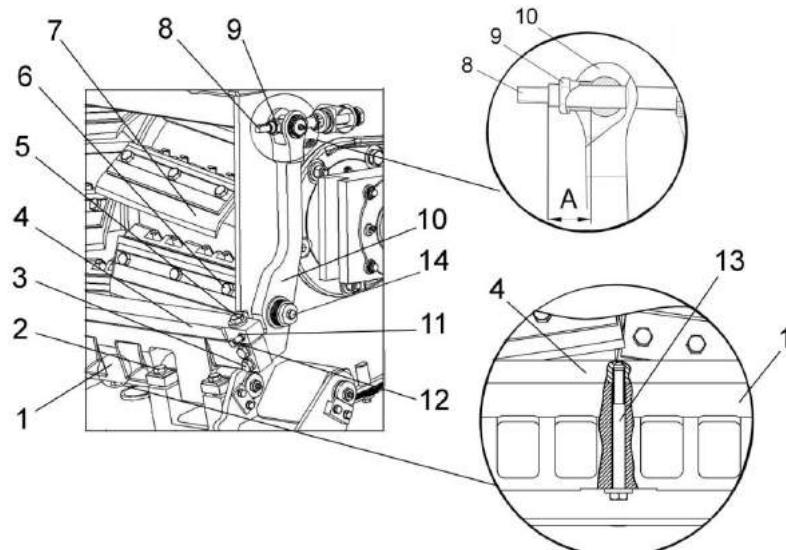
1 – опора противорежущего бруса; 2, 3, 5, 6, 12, 13, 14 – болты; 4 – противорежущий брус; 7 – нож; 8 – винт; 9, 11 – гайки; 10 - рычаг
