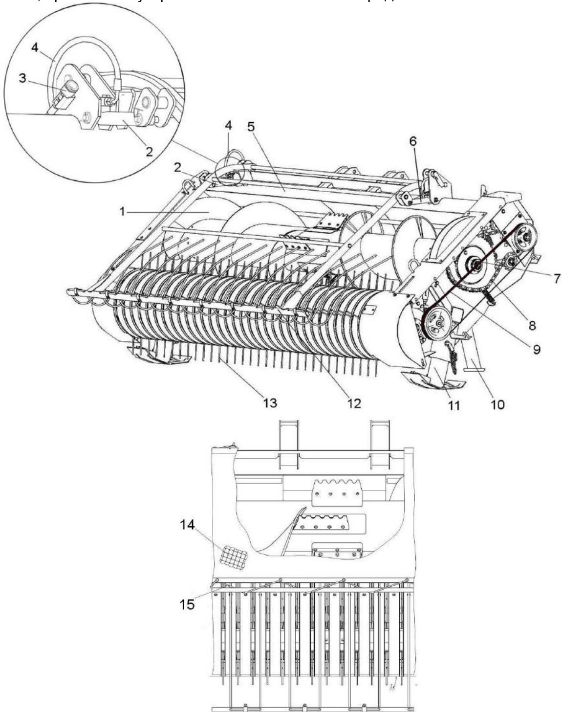
1 - шнек; 2, 6 – гидроцилиндры; 3 – полумуфта наружная с рукавом; 4 – рукав гидравлический; 5 – рама; 7 – муфта предохранительная; 8 – цепь; 9 – ремень; 10 – стойка; 11 – башмак; 12 – устройство прижимное; 13 – устройство подбирающее; 14 - защитный экран; 15 - шнур
