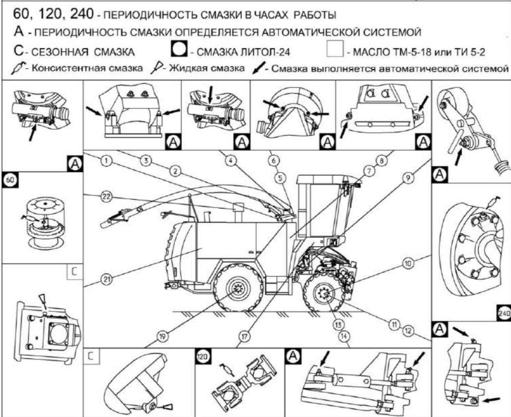
Рисунок 3.1 – Схема смазки самоходного измельчителя (вид справа)
