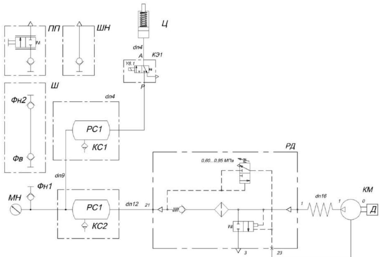
КМ – компрессор; КС1, КС2 – краны слива конденсата; КЭ1 – клапан электромагнитный;
