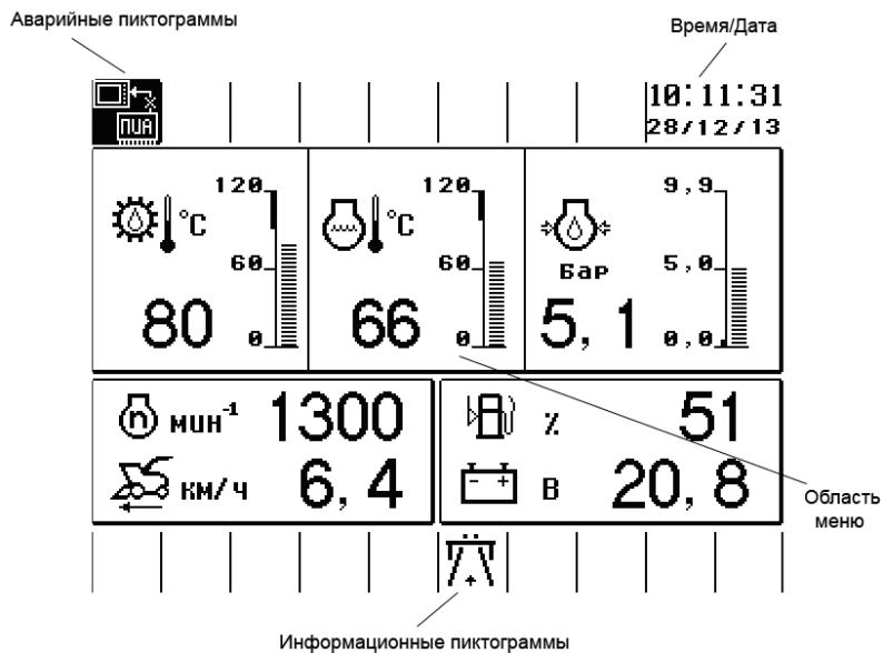
Рисунок 1.27 – Области на экране терминала
