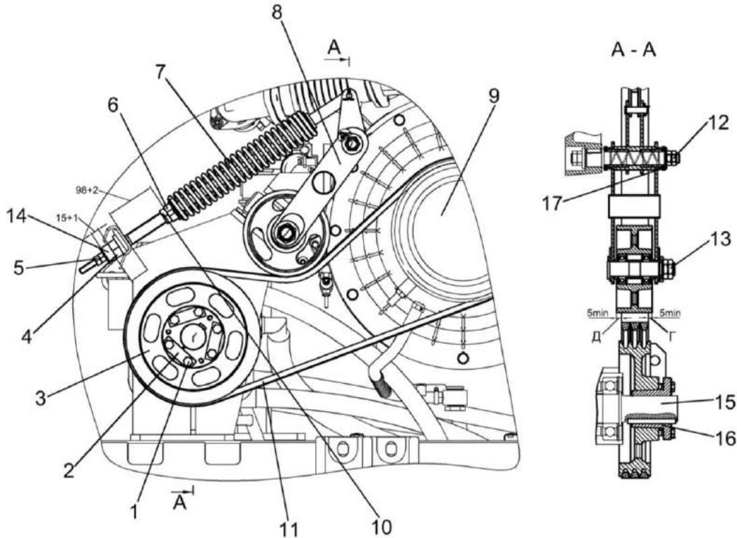
1 – болт; 2 – пластина; 3, 9 – шкивы; 4 - винт; 5, 10, 12, 13 – гайки; 6 – пробка; 7 – пружина; 8 – рычаг; 11 – ремень; 14 – амортизатор; 15 – вал; 16 – ступица, 17 – шайба
