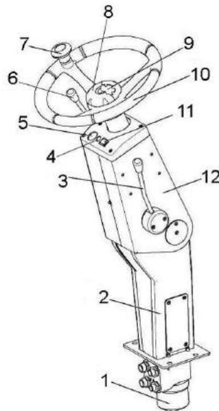
1 - насос дозатор; 2 – стойка; 3 - рукоятка фиксации угла наклона колонки; 4 – контрольная лампа дальнего света; 5 – кнопка включения аварийной сигнализации; 6 – подрулевой переключатель; 7 - ручка; 8 - крышка; 9 – зажим; 10 - колесо рулевое; 11 - контрольная лампа указателей поворотов; 12 - кожух
