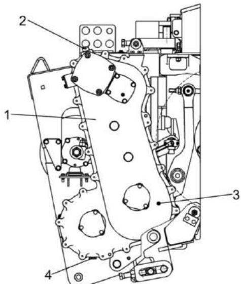
1 – редуктор привода питающего аппарата; 2 – сапун; 3 – пробка контрольная; 4 – пробка сливная
