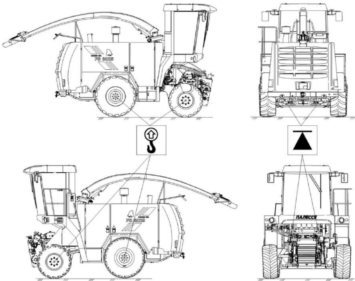
Рисунок 6.2 – Точки строповки самоходного измельчителя
