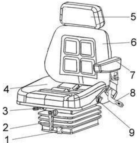
1 – маховик регулировки вертикального перемещения сиденья; 2 – рукоятка регулировки системы подпрессоривания сиденья; 3 – рычаг фиксации продольного перемещения сиденья; 4 – подушка сиденья; 5 – подголовник; 6 – спинка; 7 – подлокотник; 8 – ремень безопасности; 9 – рычаг фиксации наклона спинки
