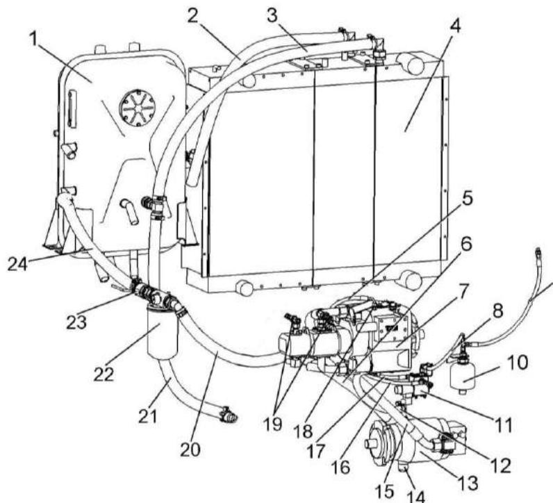
1 – масляный бак; 2, 3, 12, 20, 21, 24 – рукава низкого давления; 4 – масляная секция радиатора; 5, 6, 8, 9, 15, 16, 17 – рукава высокого давления; 7 – гидронасос трехсекционный; 10 – пневмогидроаккумулятор; 11 – гидроблок включения главного привода; 13 – гидромотор; 14 – полумуфта заправочная вспомогательная; 18 – точка диагностическая давления подпитки; 19 – точки диагностические; 22 – фильтр всасывающий; 23 – кран
