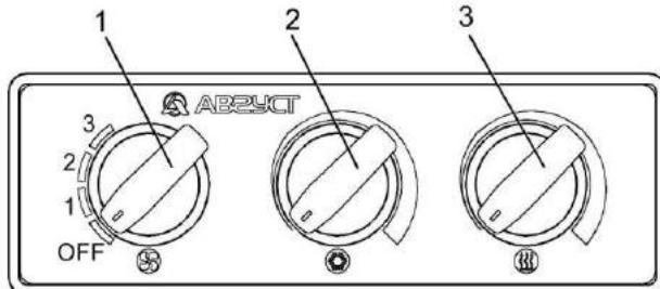
1 – выключатель вентилятора; 2 – регулятор температуры охлаждения; 3 – регулятор температуры отопления
