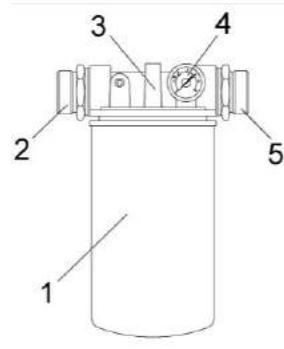
1 – фильтроэлемент; 2, 5 – штуцера; 3 – головка фильтра; 4 – вакуумметр для всасывающего фильтра (манометр для сливной фильтра)
