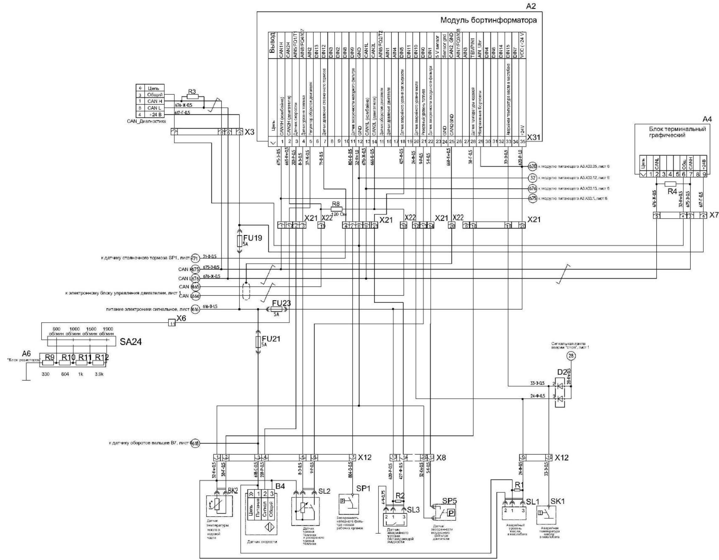
Рисунок Б.5 – Схема электрическая принципиальная комбайна (лист 5)
