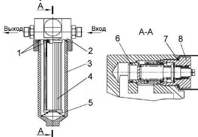
1, 6, 7, - кольца уплотнительные; 2 – головка фильтра; 3 – стакан; 4 - фильтроэлемент; 5 – пружина; 8 – клапан-сигнализатор
