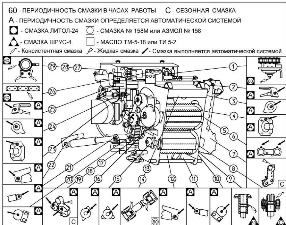
Рисунок 3.3 – Схема смазки питающе-измельчающего аппарата
