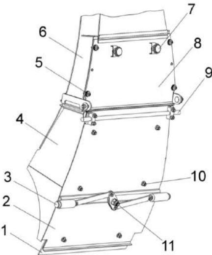
1 – лист сменный; 2 – основание; 3, 5 - фиксаторы; 4 – камера приемная; 6 – простоявка; 7 - ручка; 8 – крышка; 9 – ось; 10 – болт; 11 - втулка
