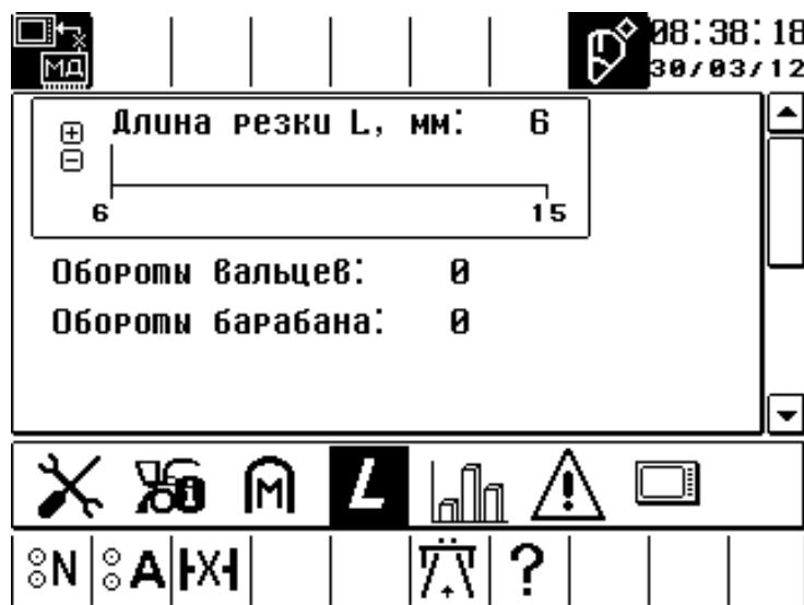
Рисунок 1.33 – раздел «Установка длин резок»
