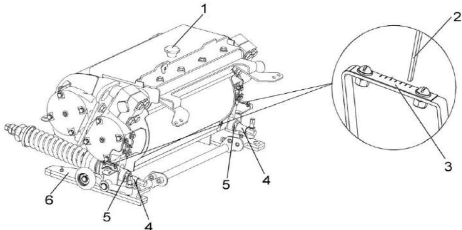
1 – ручка; 2 - указатель; 3 – шкала; 4 – тяга; 5 – гайка; 6 – корпус;
