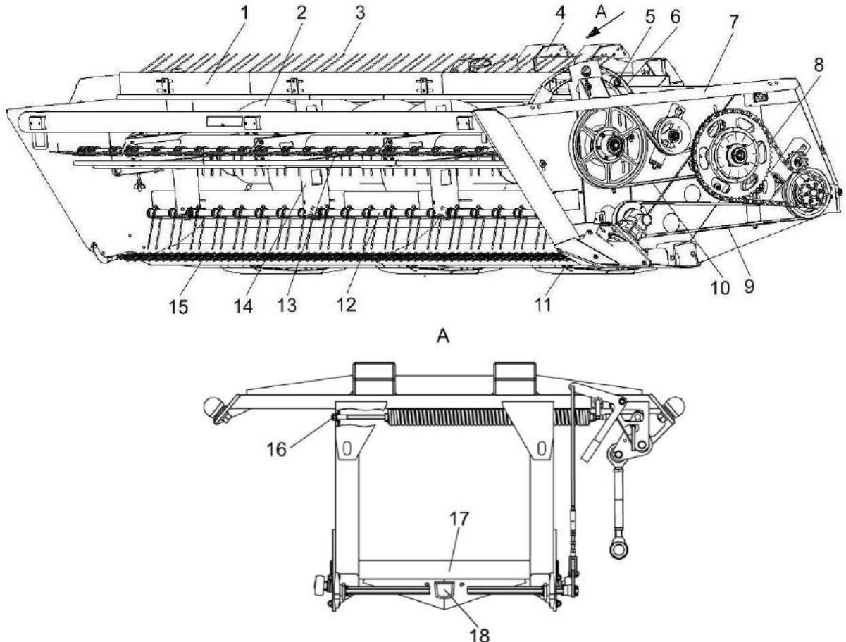
1 – планка мотовила; 2 – шнек; 3 – зуб пружинный; 4 – рамка переходная; 5 – ролик; 6 – дорожка направляющая; 7 – рама; 8 – цепная передача привода шнека; 9 – ременная передача привода режущего аппарата; 10 – ременная передача привода мотовила; 11 – башмак; 12, 13 - граблины; 14 – мотовило; 15 – режущий аппарат; 16 – болт; 17 – рамка; 18 – шарнир
