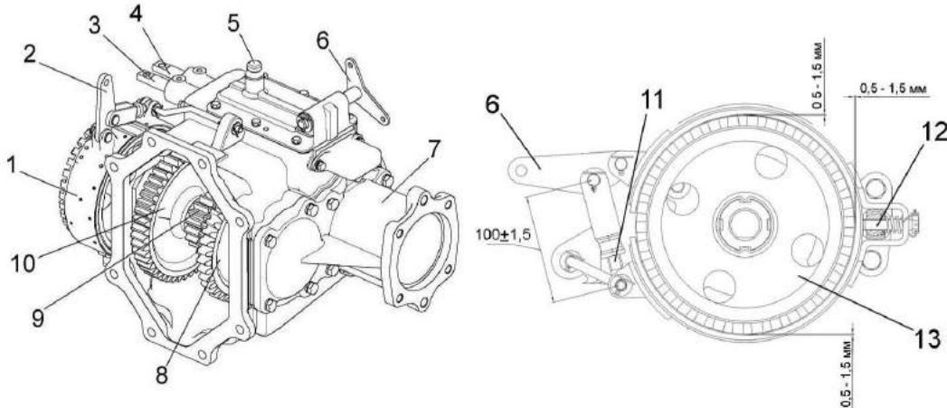
1 – лента тормоза стояночного; 2 – рычаг; 3 - шток переключения 2-й передачи; 4 - шток переключения 1-й и 3-й передач; 5 – сапун; 6 – рычаг механизма блокировки; 7 – стакан; 8, 9, 10 - блоки шестерен; 11 – ушко; 12 – болт; 13 - шкив
