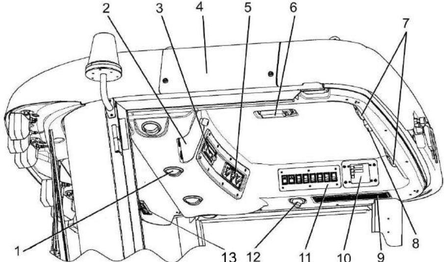
1 – дефлекторы; 2 – охлаждаемый бокс; 3 – автомагнитола (опция); 4 – крышка установки воздушного фильтра; 5 – блок управления кондиционером; 6 – светильник автотранспортный; 7 – динамики автомагнитолы; 8 – блок предохранителей; 9 – фильтр рециркуляции воздуха; 10 – пульт управления ОВК; 11 – панель выключателей; 12 – плафон индивидуального освещения; 13 – дефлекторы обдува ветрового стекла
