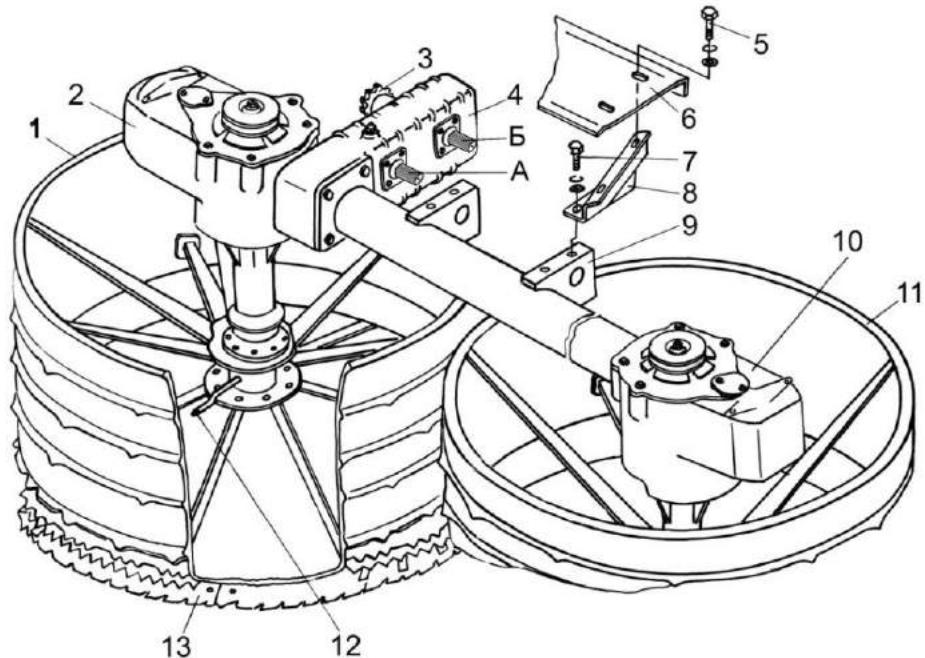
1, 11 – барабаны; 2, 10 – конические редуктора; 3 – звездочка выходного вала; 4 – цилиндрический редуктор; 5, 7 – болты; 6 – крышка; 8, 9 – кронштейны; 12 – масленки; 13 – режущий ротор
