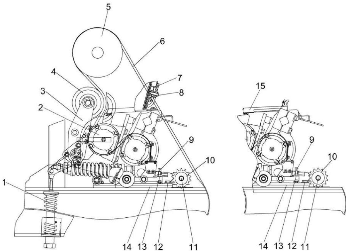
1 – пружина; 2 – доизмельчающее устройство; 3 – рычаг; 4 – ролик; 5 – шкив;
