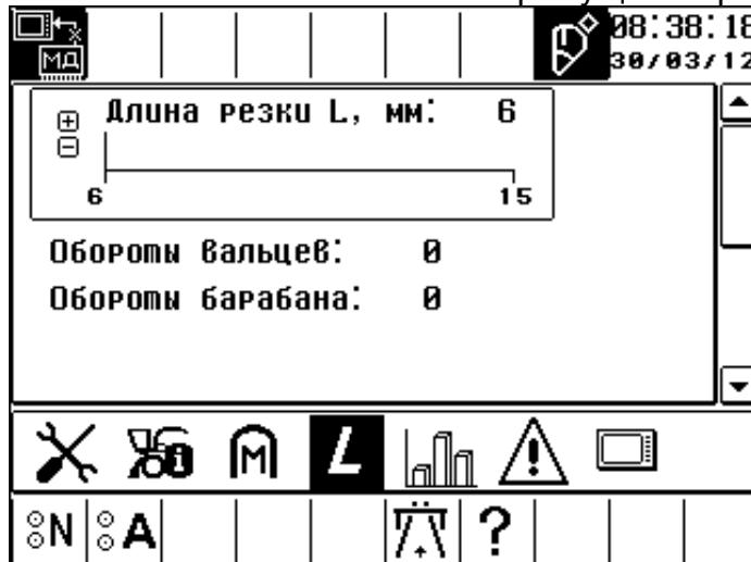
Рисунок 2.22 – Установка длины резки
