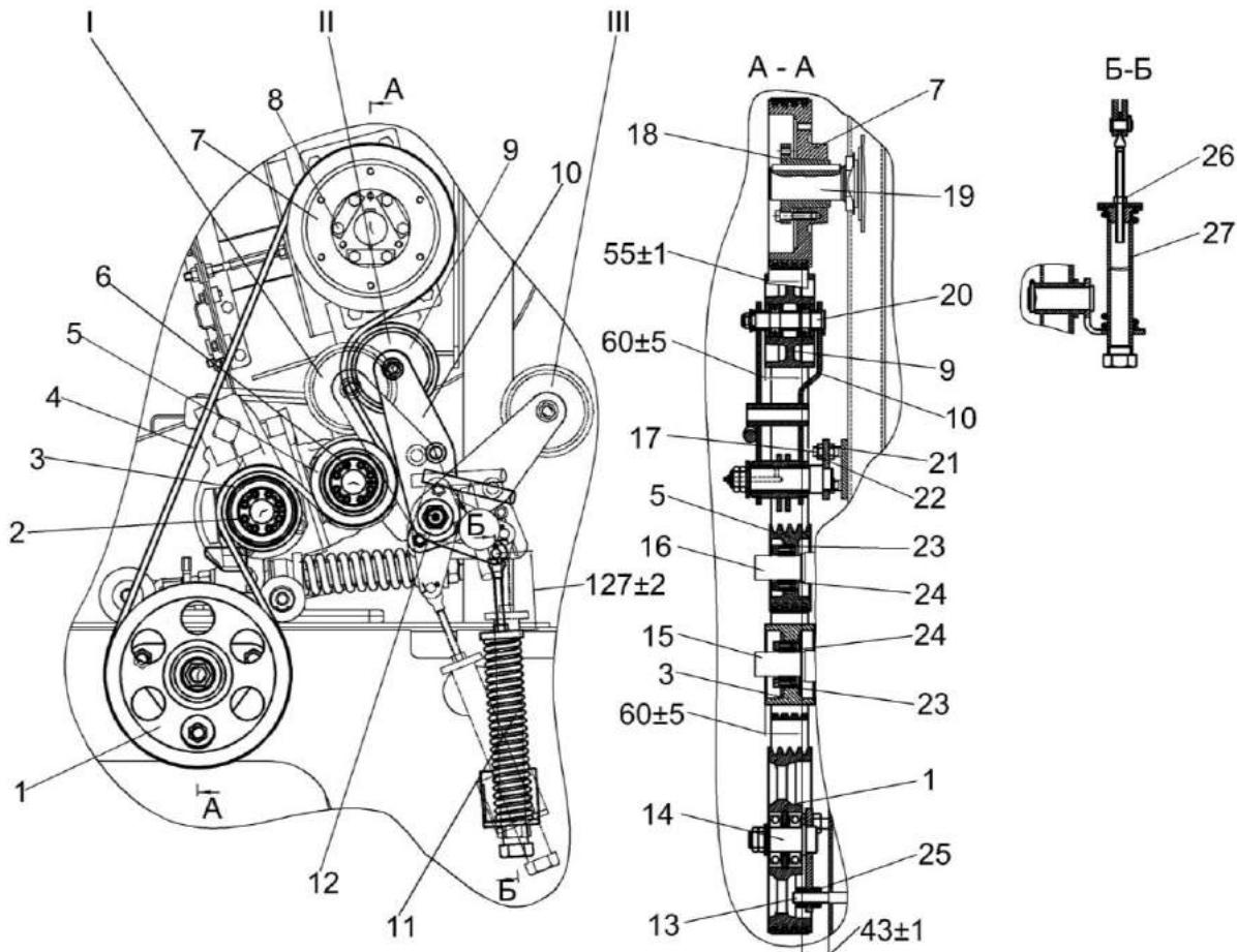
1, 3, 5, 9 – ролики; 2, 6 – винты; 4 – ремень; 7 – шкив; 8 – болт; 10 – рычаг; 11 – пружина; 12, 14 – опоры; 13 – шпилька; 15, 16, 19 – валы; 17 - шпилька; 18 – ступица; 20 – ось; 21,22, 25, 26 – гайки; 23, 24 – втулки; 27 – гильза
