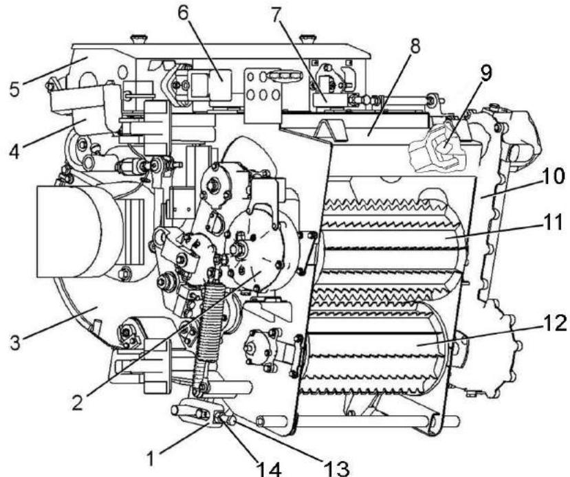
1, 7 - скобы; 2 – редуктор привода верхних вальцов; 3 - измельчающий аппарат; 4 – электромеханизм крышки; 5 - заточное устройство; 6 – гидромотор привода заточного устройства; 8 – рама питающего аппарата; 9 – кардан привода редуктора верхних вальцов; 10 – редуктор привода питающего аппарата; 11 – верхний валец; 12 - нижний валец; 13 – болт; 14 - контргайка
