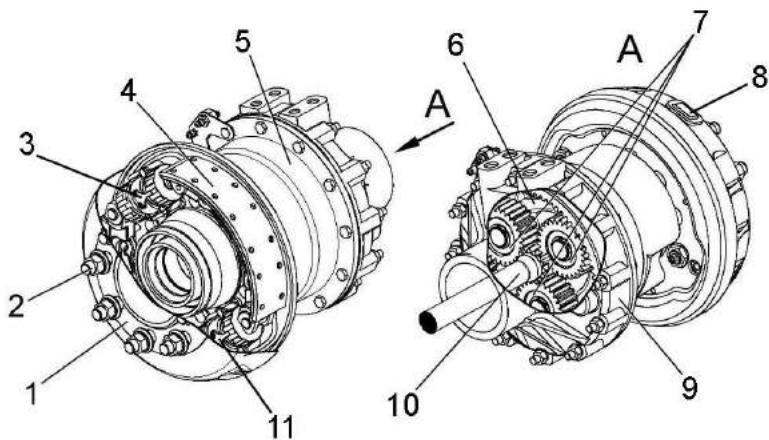
1 – барабан тормозной; 2 - гайка крепления колеса; 3, 11 – цилиндры тормозные; 4 – колодка тормозная; 5 - корпус бортового редуктора; 6 – водило; 7 - сателлиты; 8 – крышка; 9 - корпус; 10 – полуось
