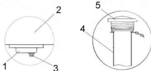
1 – отстойник; 2 – топливный бак; 3 – клапан сливной; 4 – заливная горловина; 5 – пробка заливной горловины;
