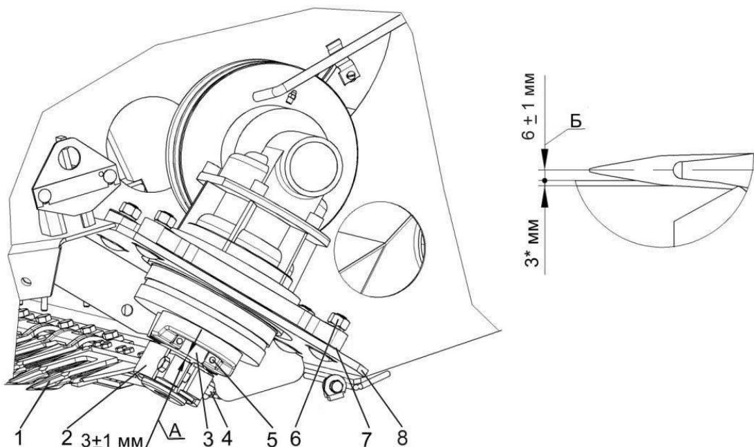
1 – режущий аппарат; 2 – головка ножа режущего аппарата; 3 – водило; 4 – болт; 5 – винт; 6 – гайка; 7 – набор прокладок; 8 - плита
