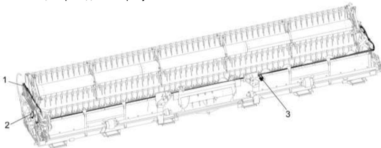
1 – гидроцилиндр горизонтального перемещения мотовила; 2 - гидроцилиндр вертикального перемещения мотовила; 3 - разъем гидравлический
