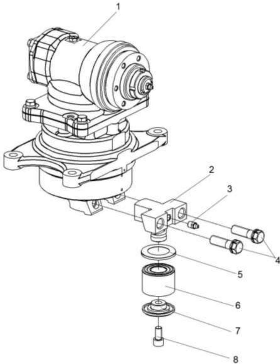
1 – редуктор; 2 – поводок; 3 – масленка; 4 - болт; 5 - пыльник; 6 - подшипник; 7 - крышка;
