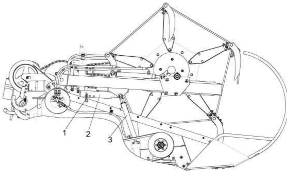
1 – гидроцилиндр подъема мотовила; 2 – упор; 3 – фиксатор
