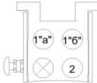
Рисунок 1.10 – Схема подключения стационарной части разъема гидравлического многофункционального
