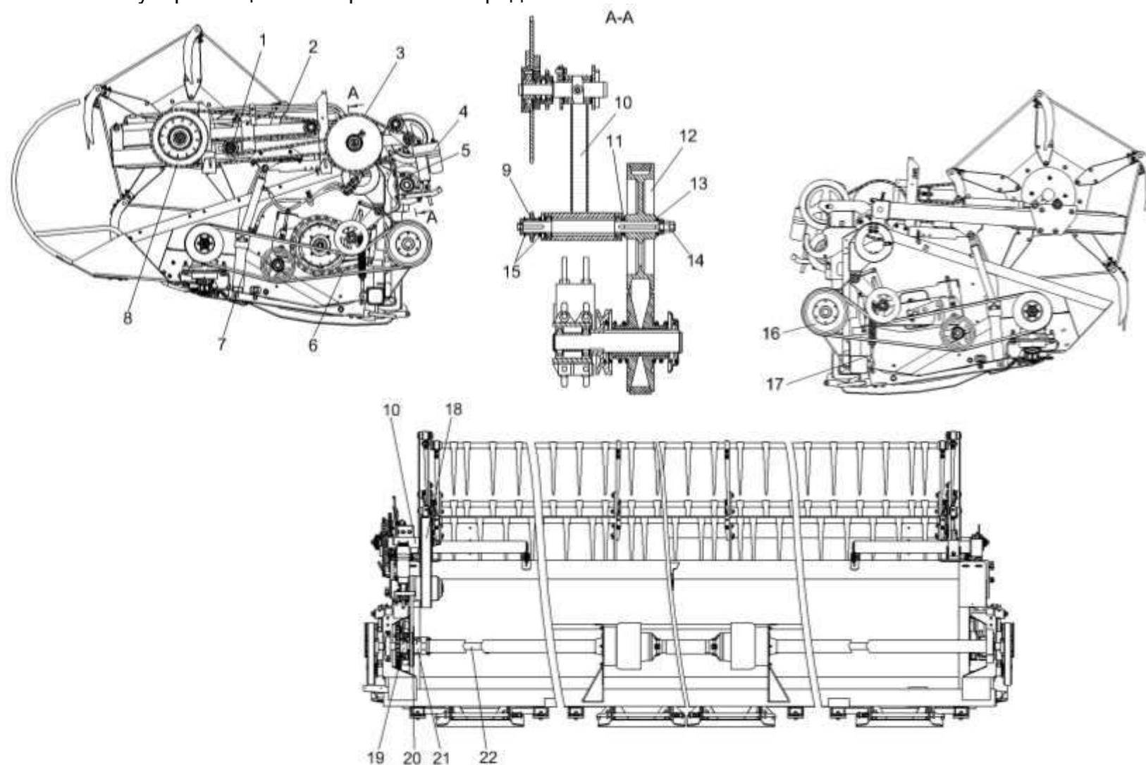
1, 9, 19 – звездочки; 2, 3, 6 – цепи; 4 - электромеханизм; 5 - вариатор; 7, 18, 20 - ремни; 8 - муфта фрикционная; 10 - устройство натяжное; 11 - шайба; 12, 16, 21 - шкивы; 13, 15 - кольца; 14 - шайба; 17 - пружина; 22 - вал
