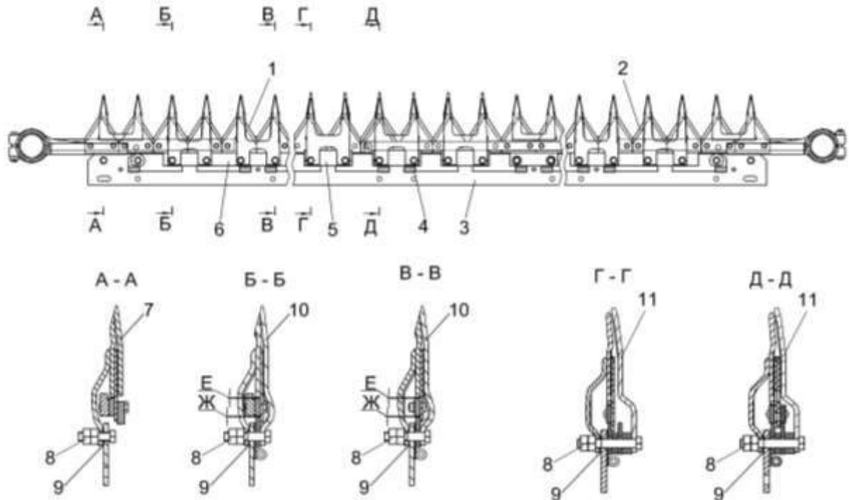
1 – нож левый; 2 – нож правый; 3 – брус пальцевый; 4 – петля; 5, 6 – пластины трения; 7 - палец направленный сдвоенный; 8 – гайки; 9 – прокладка; 10 - палец сдвоенный; 11 – палец
