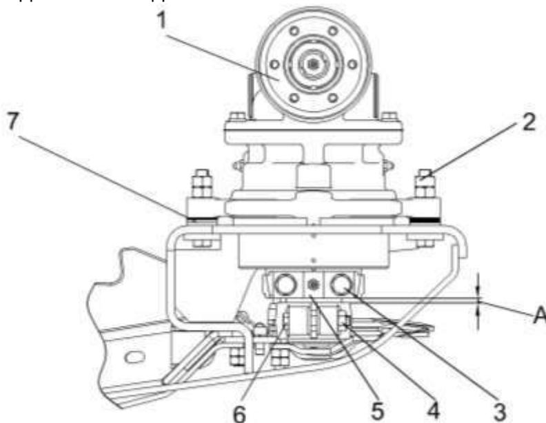
1 – редуктор; 2, 3, 6 – болты; 4 – гайка; 5 – водило; 7 – регулировочные прокладки
