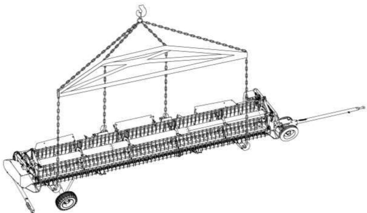
Рисунок 6.1 – Строповка жатки
