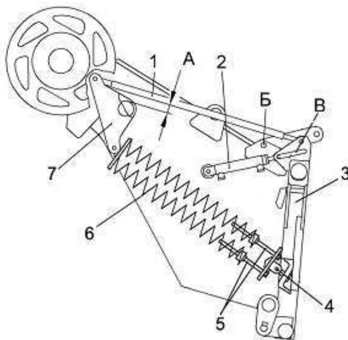
1 – тяга; 2 – гидроцилиндр; 3 - рамка переходная; 4 – шарнир; 5 - винт; 6 – пружина; 7 – рычаг
