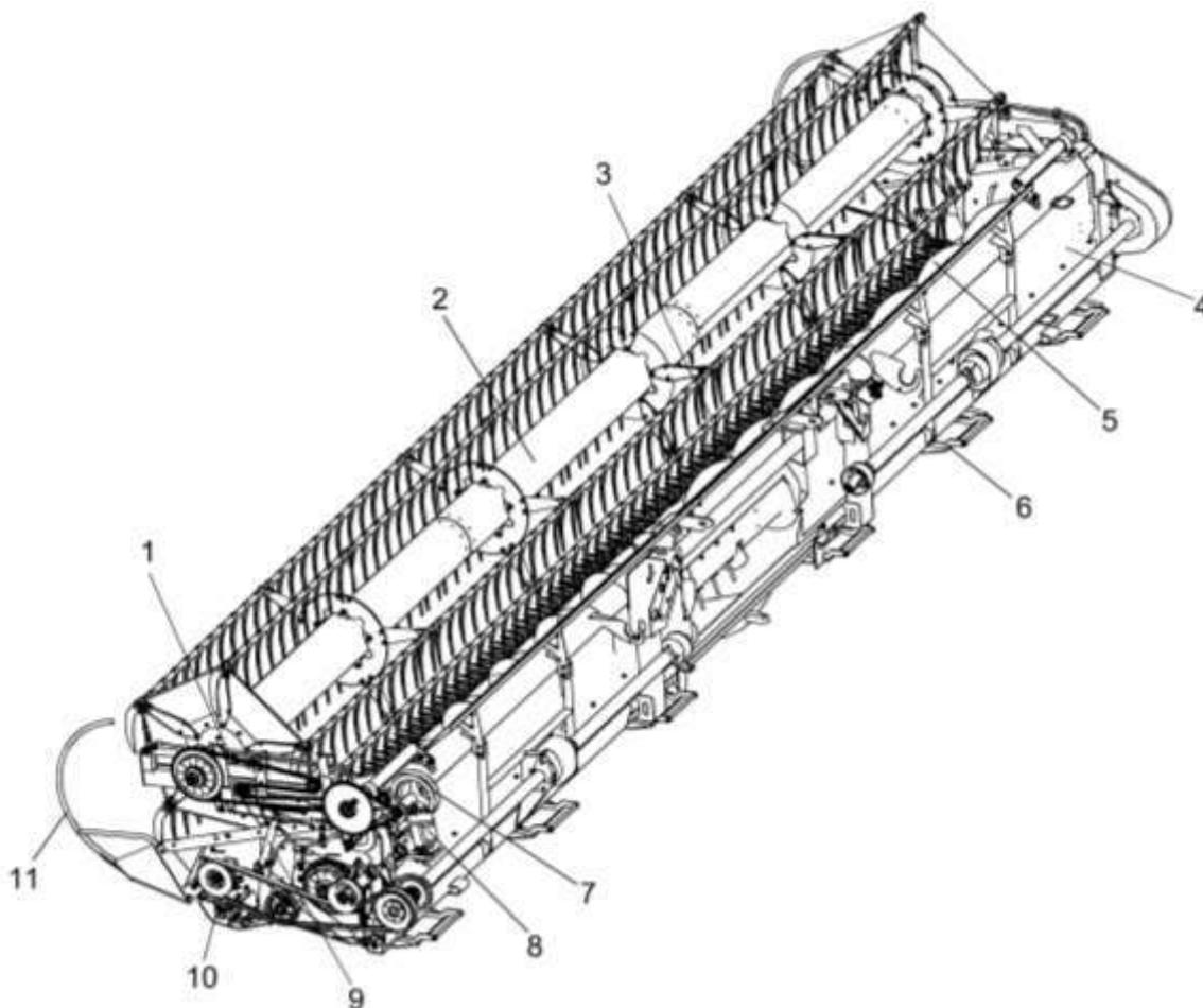
1 – гидроцилиндры выноса мотовила; 2 – мотовило; 3 – режущий аппарат; 4 – рама;
