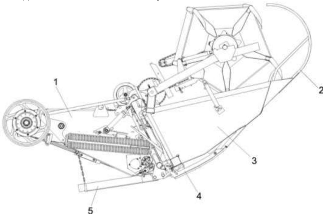
1 – камера наклонная; 2 - делитель прутковый; 3 - жатка; 4 - башмак; 5 - упор
