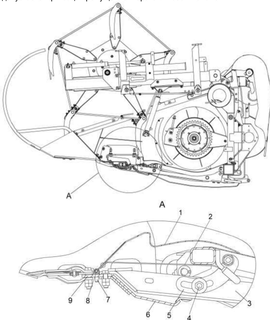
1 - щиток; 2 – рессора; 3 - рычаг; 4 – гайка; 5 – ограничитель хода; 6 - ползья; 7 – винт; 8 – ось; 9 – брус режущего аппарата
