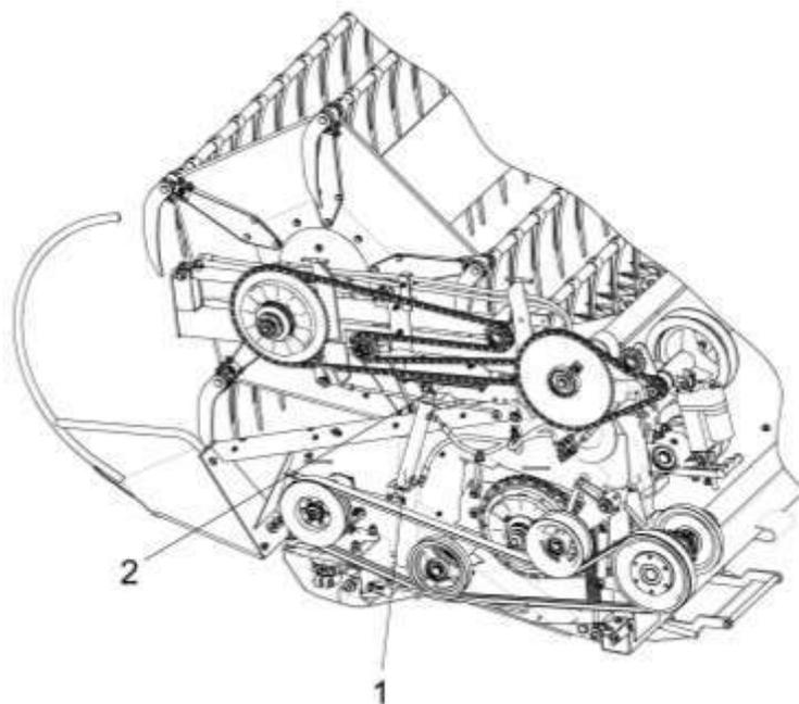
1 – гидроцилиндр подъема мотовила по высоте; 2 – гайка
