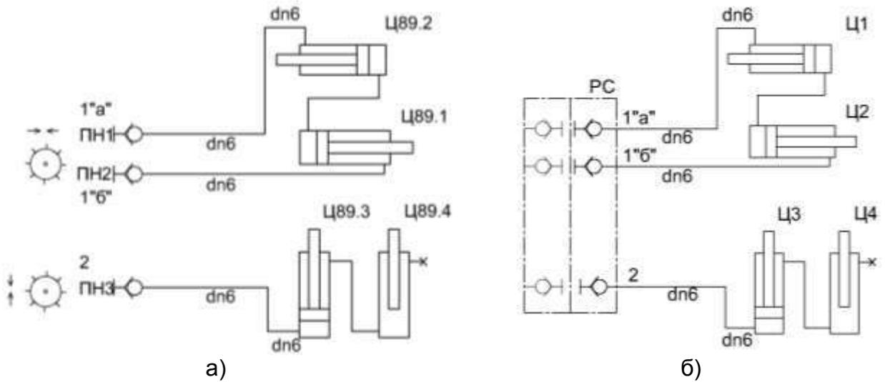
а) Ц89.1, Ц89.2 - гидроцилиндры горизонтального перемещения мотовила; Ц89.3, Ц89.4 - гидроцилиндры вертикального перемещения мотовила; ПН1, ПН2, ПН3 - муфты
