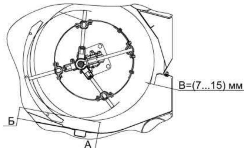
А – зазор между витками шнека и днищем жатки;
