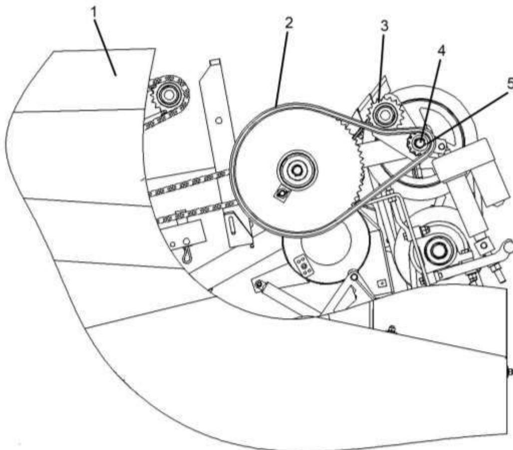
1 – ограждение; 2 – цепь; 3 – звездочка натяжная; 4 - болт; 5 - звездочка
