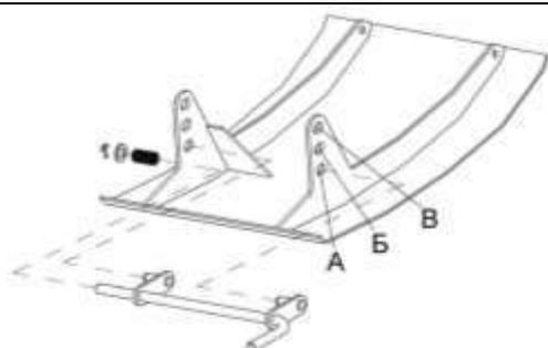
2.3.8 При работе жатки без копирования режущим аппаратом рельефа поля рычаги подвески режущего аппарата должны быть зафиксированы в верхнем положении или опущены вниз не более чем на 50 мм по концам сегментов. Фиксация рычагов производится зажимом гайки 4 (рисунок 1.4). Необходимую высоту среза установите в соответствии с таблицей 2.1.
