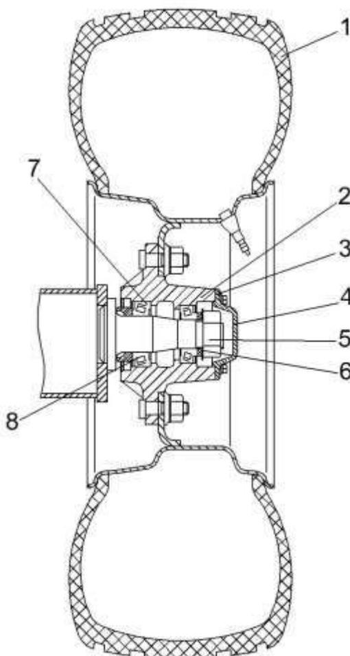
1 - колесо; 2 – ступица; 3 – прокладка; 4 - крышка; 5 - гайка; 6 - шайба стопорная; 7, 8 - подшипники
