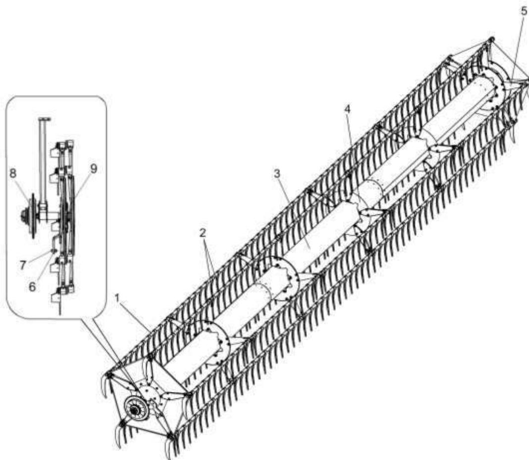
1 – граблина; 2 – зуб пружинный; 3 – луч; 4 – вал мотовила; 5 – диск; 6 – поводок; 7 – ролик; 8 – приводная звездочка с предохранительной муфтой; 9 – эксцентриковый механизм
