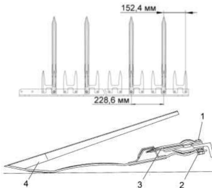
1 – болт крепления стеблеподъемника; 2 – контргайка; 3 – палец режущего аппарата; 4 – стеблеподъемник
