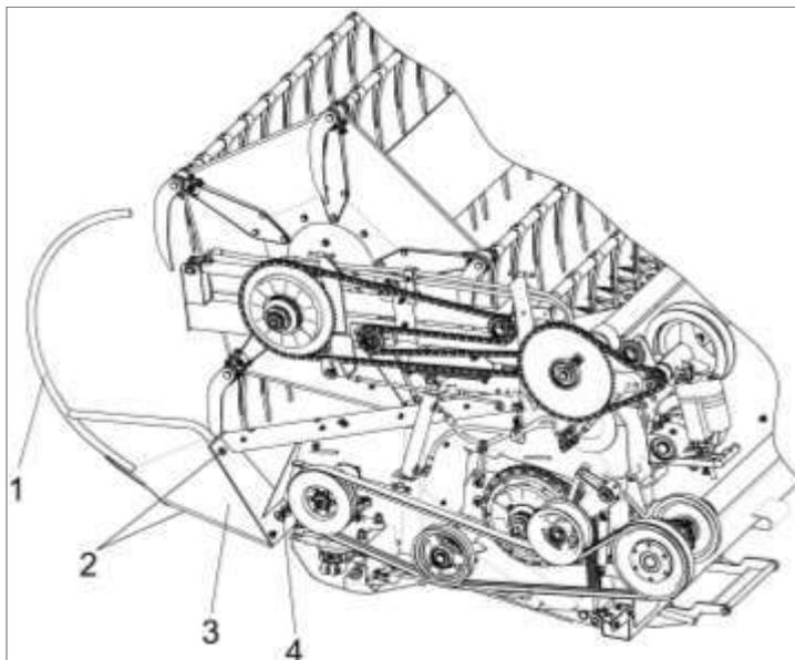
1 – прутковый делитель; 2 - болт DIN M12x20; 3 - носок; 4 - болт M12x25
