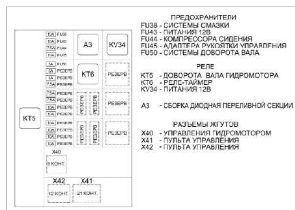
Рисунок 1.33 – Реле и предохранители пульта управления
