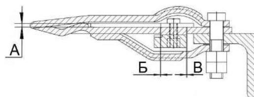
Рисунок 4.2 – Режущий аппарат
