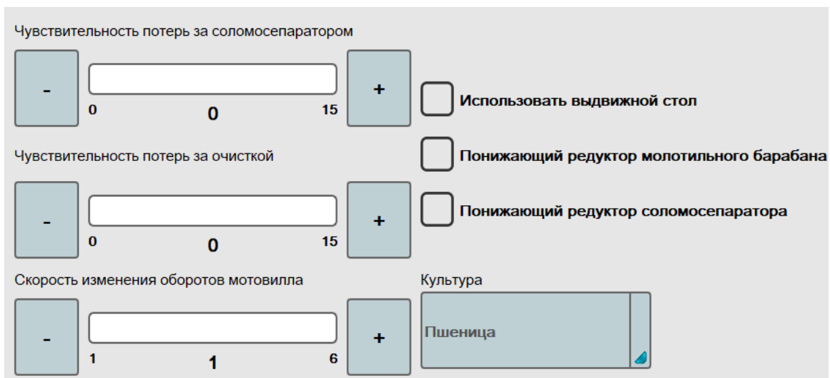
Рисунок Ж. 5 – Вид окна «Регулировки комбайна»
