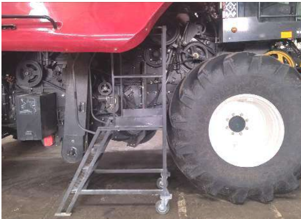
Рисунок 3.3 – Лестница с площадкой для заправки насоса АЦСС
