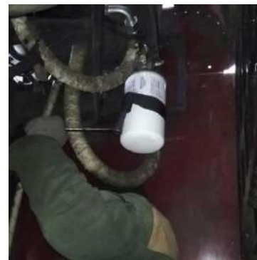
Рисунок 3.9 – Сливной фильтроэлемент, демонтируемый при помощи ключа фильтра
