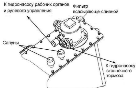
Рисунок 3.13 – Замена фильтроэлемента фильтра и сапунов
