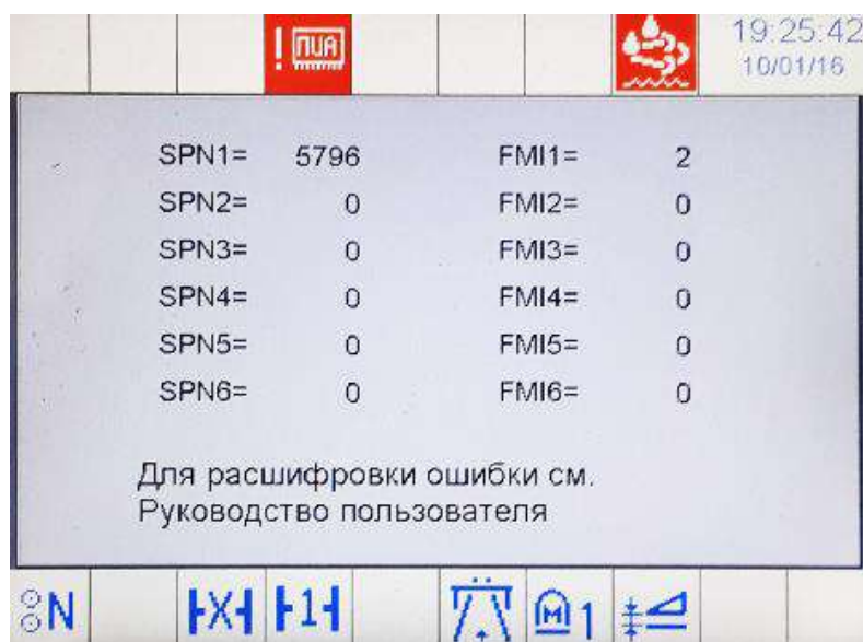
Рисунок Р.26 – Экран «Ошибки двигателя»: ошибки присутствует
