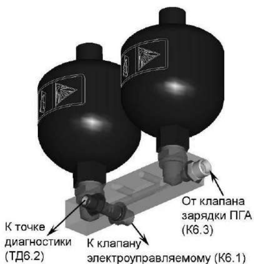
Рисунок 1.70 – Блок пневмогидроаккумуляторов (ПГА6.1, ПГА6.2)
