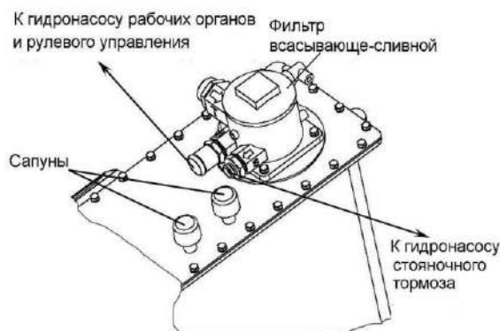
Рисунок 3.13 – Замена фильтроэлемента фильтра и сапунов
