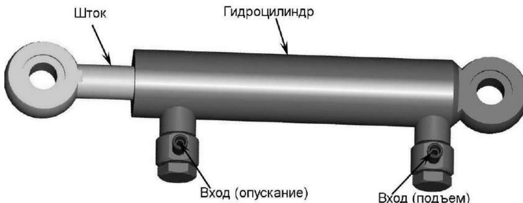
Рисунок 1.55 – Гидроцилиндр подъема силосопровода (Ц2.6)
