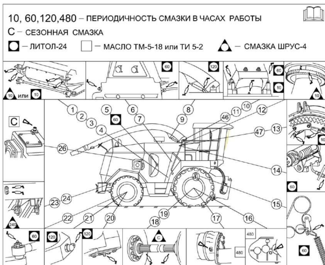
Рисунок 3.14 – Схема смазки измельчителя КВК 0100000 (вид справа)
