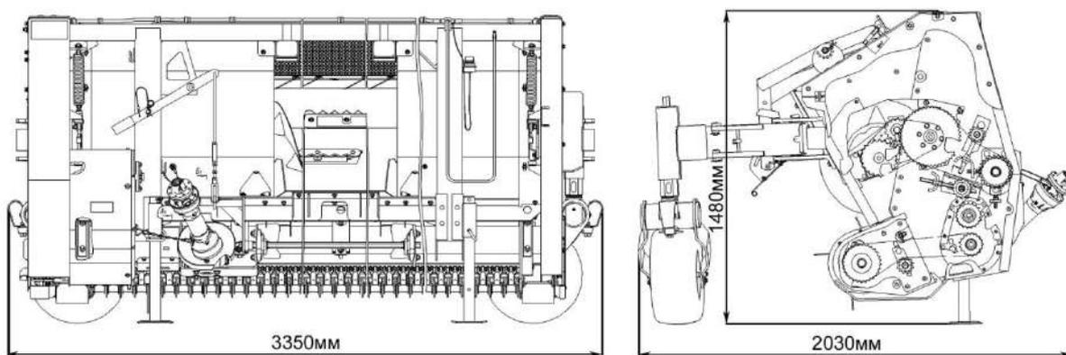
Рисунок 1.2 – Габаритные размеры подборщика
