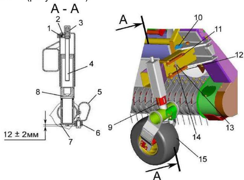
1 – пружина; 2 – шарик; 3 – наконечник; 4 – винт регулировочный; 5 – пружина; 6 – ролик; 7 – копир; 8 – ось колеса; 9 – линейки; 10 – фиксатор; 11 – упор; 12 – шплинт быстроразъемный; 13 – планка; 14 – болт; 15 – колесо флюгерное
