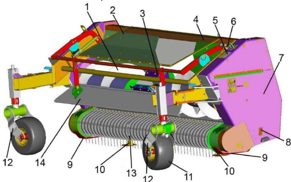
1 – шнек; 2 – защитный экран; 3 – лопатка шнека; 4 – рама; 5 – табличка фирменная; 6 – фиксатор; 7 – ограждение; 8, 12 – световозвращатели; 9 – башмаки; 10 – опоры стояночные; 11 – колеса флюгерные; 13 – устройство подбирающее; 14 – устройство прижимное
