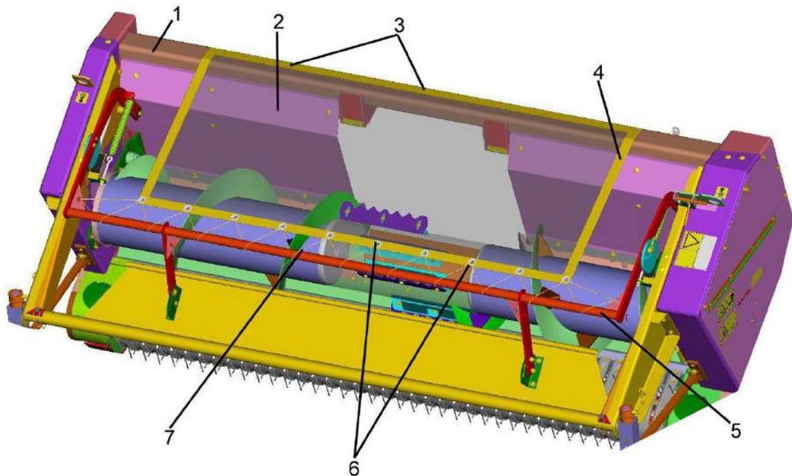
1 – верхняя балка рамы; 2 – сетка полимерная; 3 – болты; 4 – ткань тентовая; 5 – труба рамки прижимного устройства; 6 – отверстия армированные; 7 – шнур
