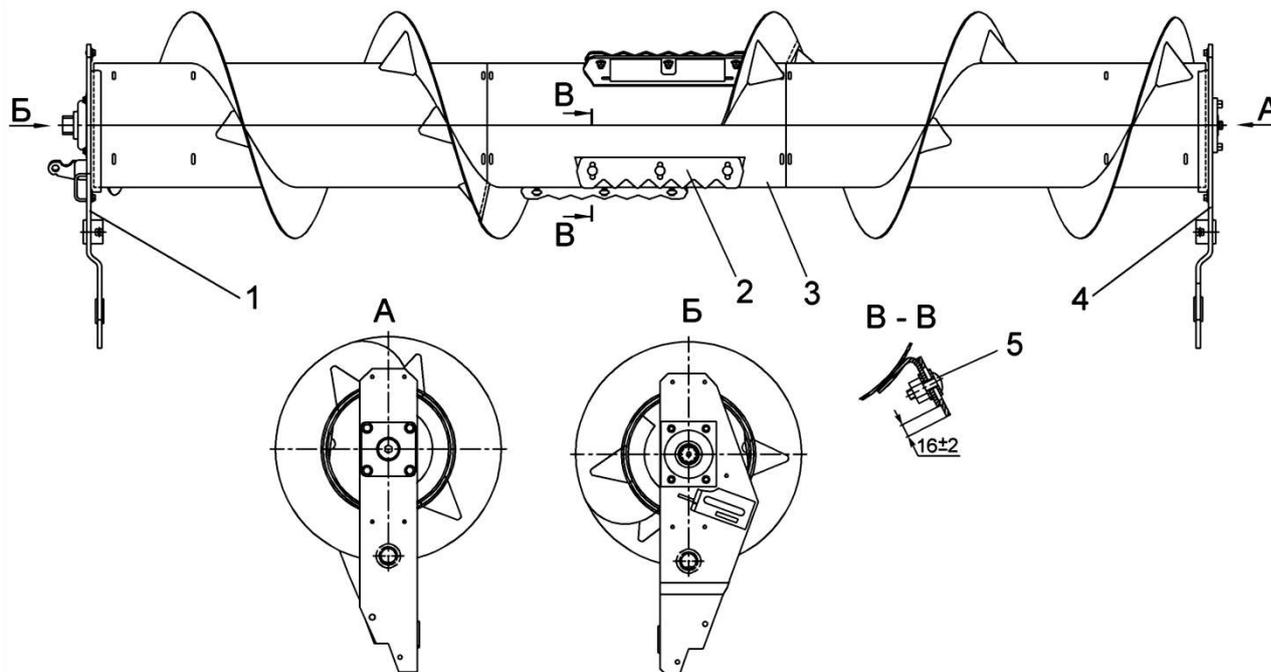
1, 4 – рычаги; 2 – лопатка; 3 – шнек; 5 – винт
