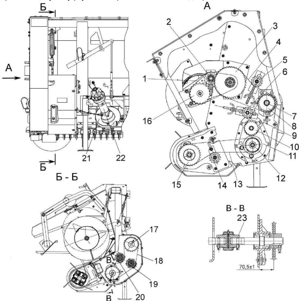
1 – цепная передача привода шнека; 2, 5, 6, 14 – натяжные устройства; 3, 8, 10, 12, 15, 16 – звездочки приводов; 4, 9, 18 – промежуточные цепные передачи; 7, 17 – вал контрприводной подборщика; 11 – редуктор; 13 – цепная передача привода подбирающего устройства; 19 – звездочка натяжная; 20 – звездочка обводная; 21 – редуктор; 22 – вал карданный; 23 – муфта шлицевая
