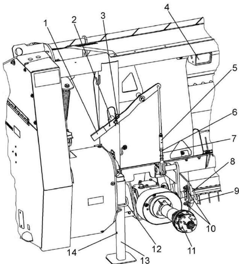
1 – рукоятка; 2 – бонка; 3 – фиксатор пружинный; 4 – кронштейн; 5 - стяжка; 6, 10 – гайки; 7 – тяга; 8 – ловитель; 9 – крюк; 11 - вал карданный; 12 – фиксатор; 13 – опора стояночная; 14 – отверстие для фиксации опоры стояночной в крайнем верхнем положении
