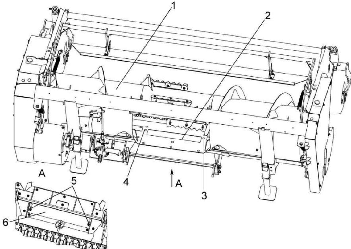
1 – шнек; 2 – окно камнеуловителя; 3, 4 – болты фиксирующие; 5 – гайки; 6 – щиток
