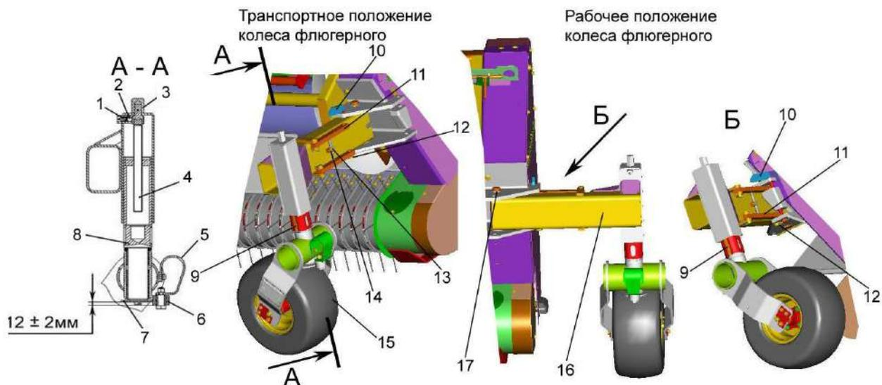
1 – пружина; 2 – шарик; 3 – наконечник; 4 – винт регулировочный; 5 – пружина; 6 – ролик; 7 – копир; 8 – ось колеса; 9 – линейки; 10 – фиксатор; 11 – упор; 12 – шплинт быстро-съемный; 13 – планка; 14 – болт; 15 – колесо флюгерное; 16 – опора; 17 – ось опоры
