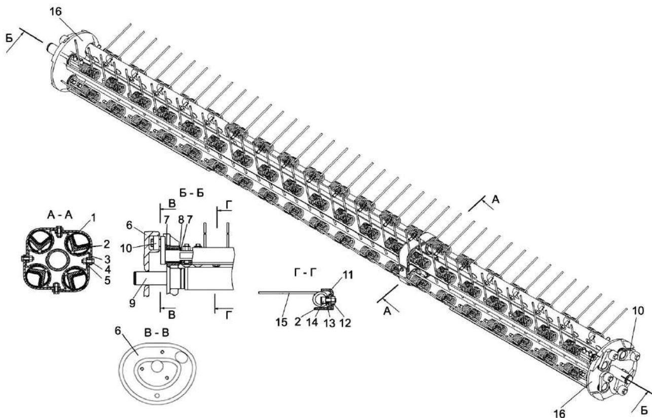
1 – опора; 2 – граблина; 3 – хомут; 4, 14 – болты; 5, 12 – гайки; 6 – дорожка; 7, 13 – шайбы; 8 – втулка; 9 – вал; 10 – эксцентрик; 11 – жесткость; 15 – зуб пружинный; 16 – диски
