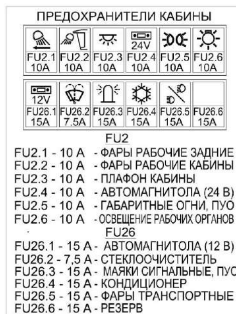
Рисунок 1.36 - Схема расположения предохранителей
