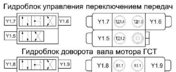
Рисунок 1.16 – Схема гидроблоков
