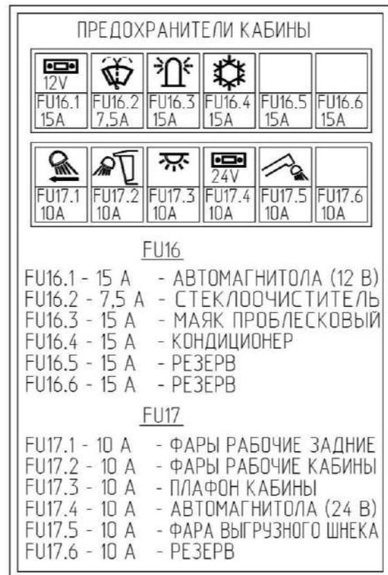
Рисунок 1.40 – Схема расположения предохранителей
