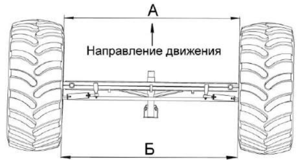
Рисунок 2.26 - Регулировка сходимости колес
