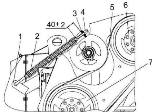
1 – натяжное устройство; 2 - пружина; 3 – сферическая шайба; 4 - регулировочный болт;
