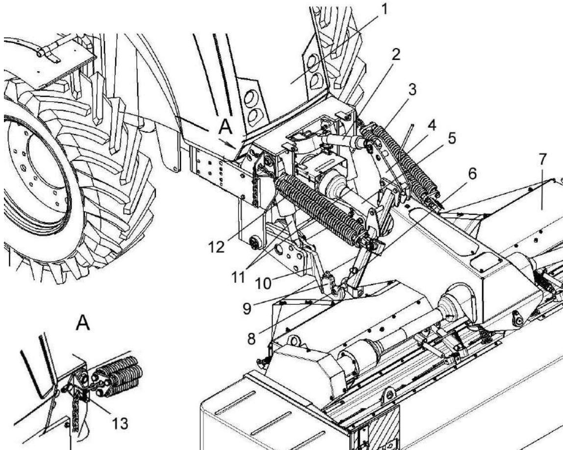
1 – трактор; 2 – верхняя тяга; 3 – отверстие; 4 – ухо; 5 – карданный вал; 6 - шаровые опоры; 7 - центральная секция; 8 – пальцы автосцепки; 9 – захват; 10 – блок нижних тяг; 11 - гидроцилиндры; 12 – блоки пружин; 13 – замок
