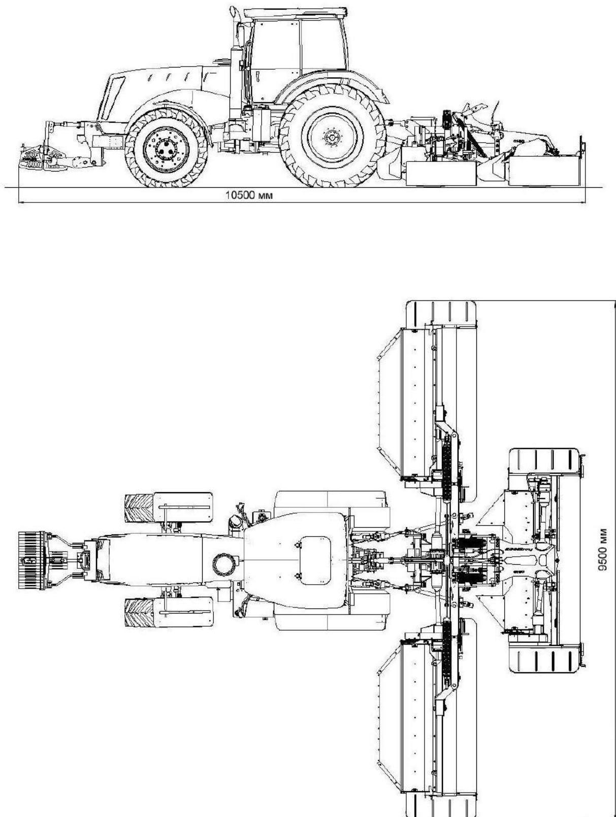
Рисунок 3.4 - Габаритные размеры косилки, в рабочем положении
