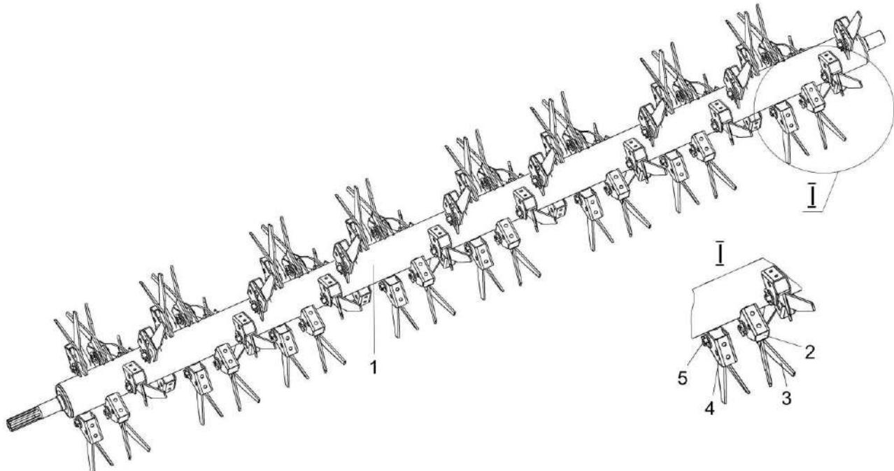
1 – вал; 2 – демпфер; 3 – бич; 4 – корпус; 5 – ось со шплинтом
