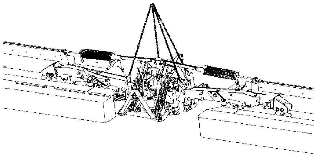
**Схема строповки центральной секции**
