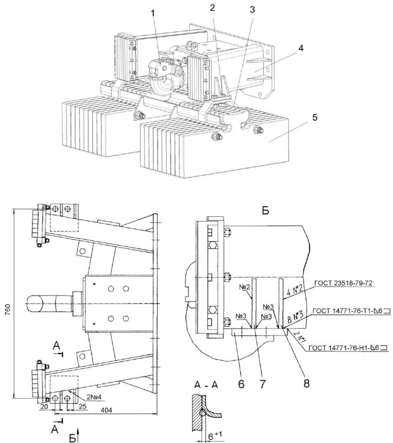
Рисунок 5.5 – Установка блока дополнительных грузов и доработка ТСУ
