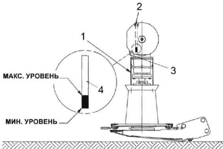
1 – щитки; 2 – заливное отверстие; 3 – сливная пробка; 4 - маслоуказатель
