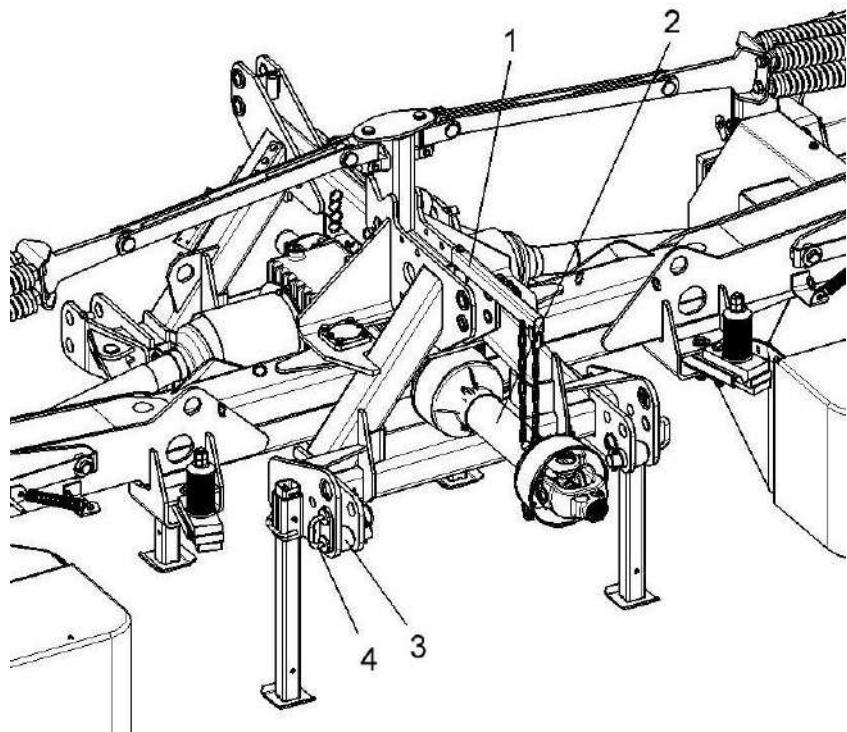
1 – подвес; 2 – карданный вал; 3 – шарнир; 4 - фиксатор
