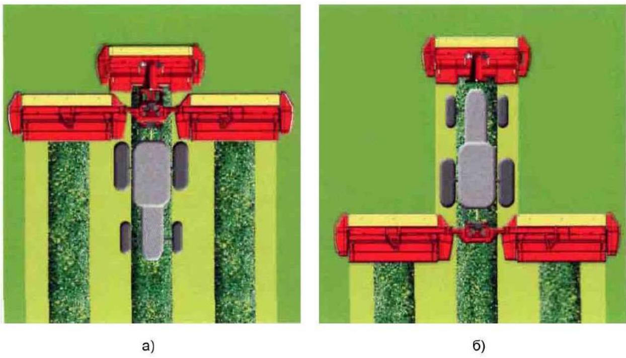
Рисунок 2.2 – Схемы технологического процесса укладки валков косилкой в агрегате с трактором
