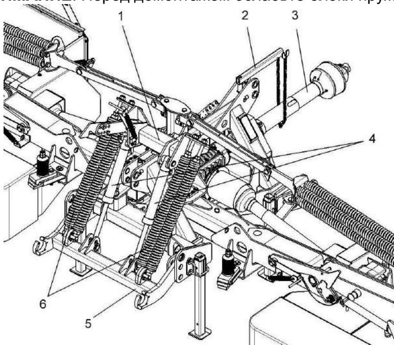
1 – кронштейн; 2 – подвес; 3 – карданный вал; 4 - гидроцилиндры; 5 – рамка; 6 – блоки пружин
