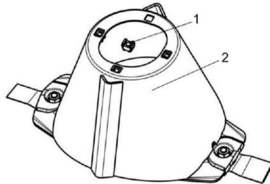
1 – закладная гайка; 2 – диск с конусом
