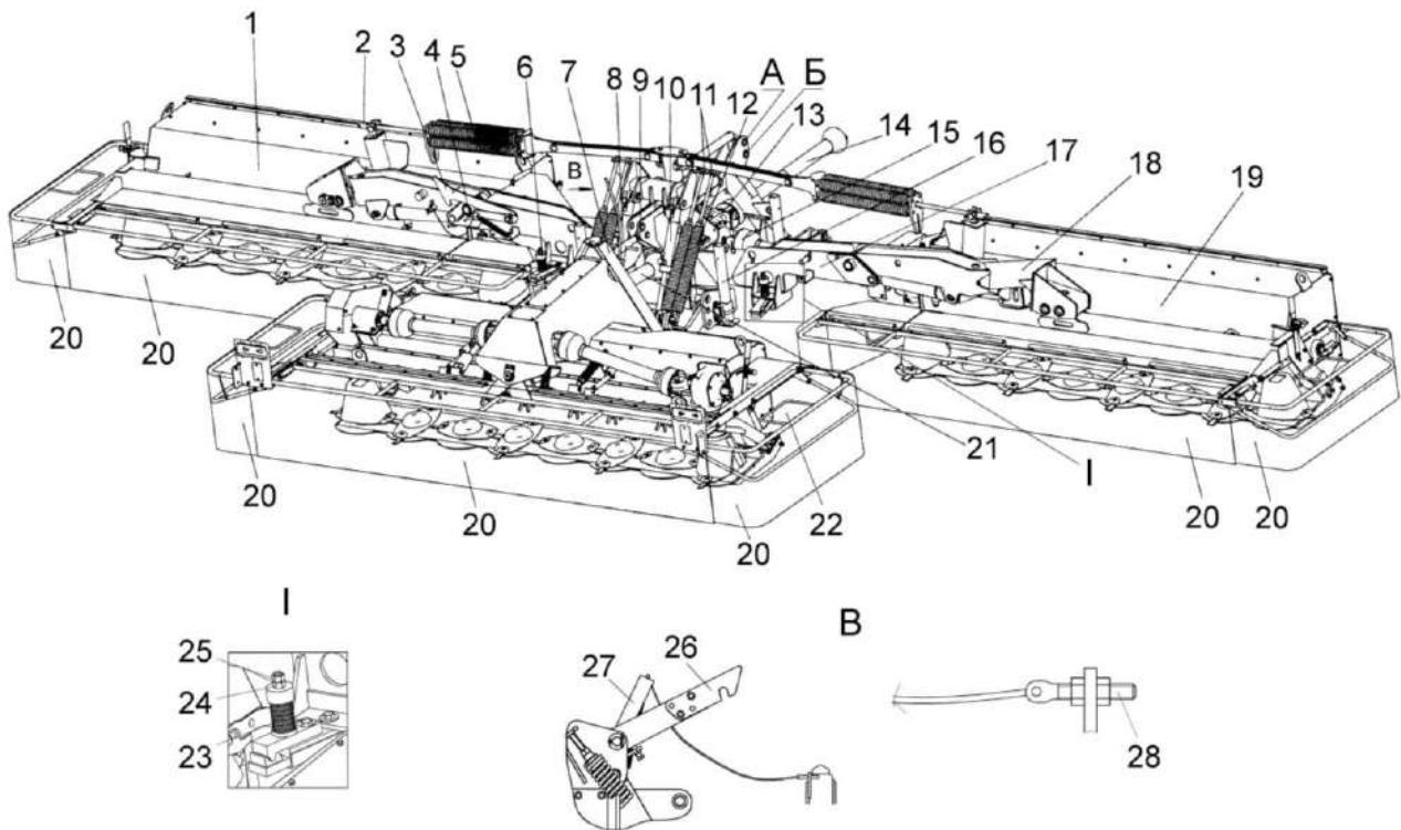
1, 19 – боковые секции; 2, 11, 28 – регулировочные винты; 3 – защелка; 4 – рукоятка; 5, 12 – пружины; 6 – предохранитель; 7 – автоматическая сцепка; 8 – верхняя тяга; 9 – рама навески; 10 – гидросистема косилки; 13 – центральный редуктор; 14 – вал карданный привода косилки; 15, 21 – валы карданные привода секций; 16 – стойка; 17, 18 – рычаги; 20 – полога секций; 22 – центральная секция; 23 – пакет тарельчатых пружин; 24 – гайка; 25 – контргайка; 26 – фиксатор; 27 – рукоятка
