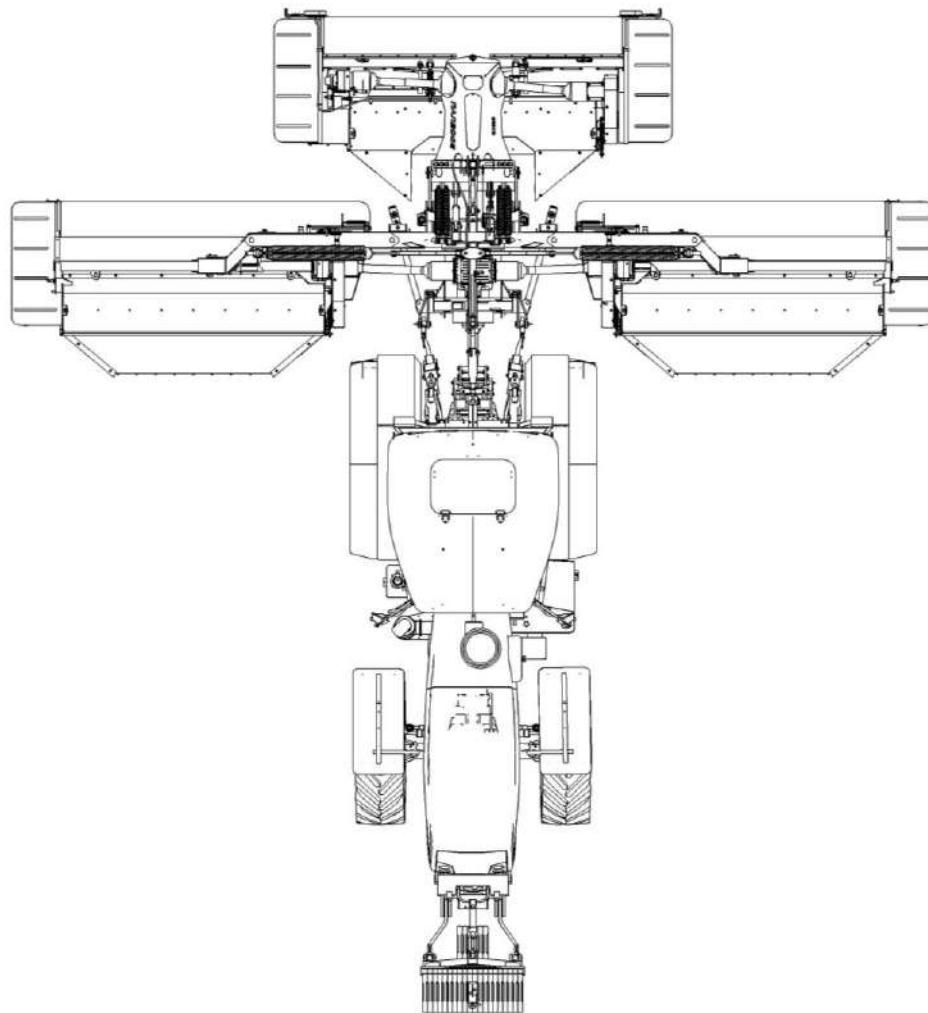
Рисунок 5.11 - Компактная навеска косилки на трактор
