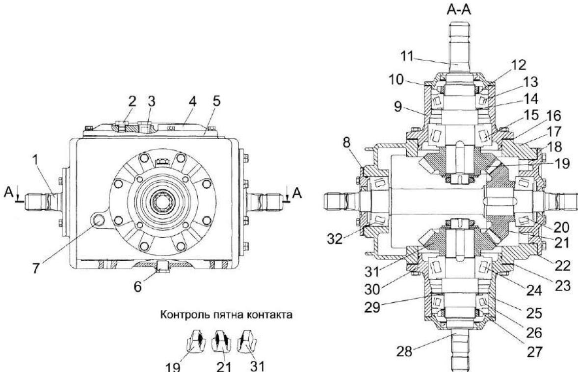
1, 11, 28 – валы; 2, 3 – пробки; 4, 18 – крышки; 5, 8, 10, 16, 22, 23 – прокладки; 6 – сливная пробка; 7 – контрольная пробка; 9, 30 – стаканы; 12, 27 – гайки со стопорными шайбами; 19, 21, 31 – шестерни; 14, 29 – втулки; 13, 15, 20, 24, 26, 32 – подшипники; 17, 25 – стаканы
