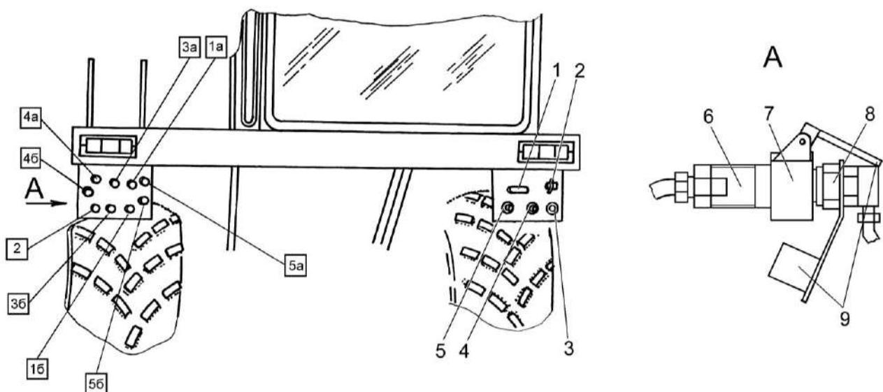
1 – розетка; 2 – соединительная головка пневмосистемы; 3 – штепсельный разъем; 4 – штепсельная розетка для подключения электрооборудования сельхозмашин (12 В); 5 – штепсельная розетка для подключения светосигнального электрооборудования прицепов (24 В); 6 - полумуфта наружная; 7 – фиксатор; 8 – полумуфта внутренняя; 9 – пластмассовые заглушки
