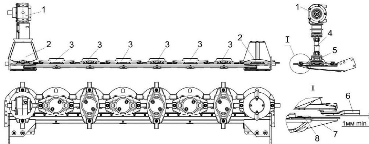
1 – конический редуктор; 2 – диски с конусом; 3 – плоские диски; 4 – карданный вал; 5 – опора; 6 – ножи; 7 – полоз; 8 – пластина
