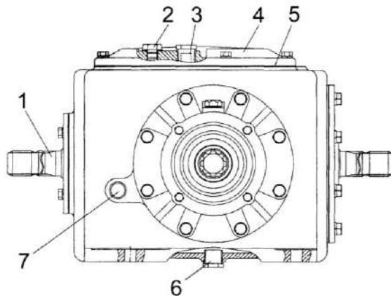
1 – вал; 2, 3 – пробки; 4 – крышка; 5 – прокладка; 6 – сливная пробка; 7 – контрольная пробка
