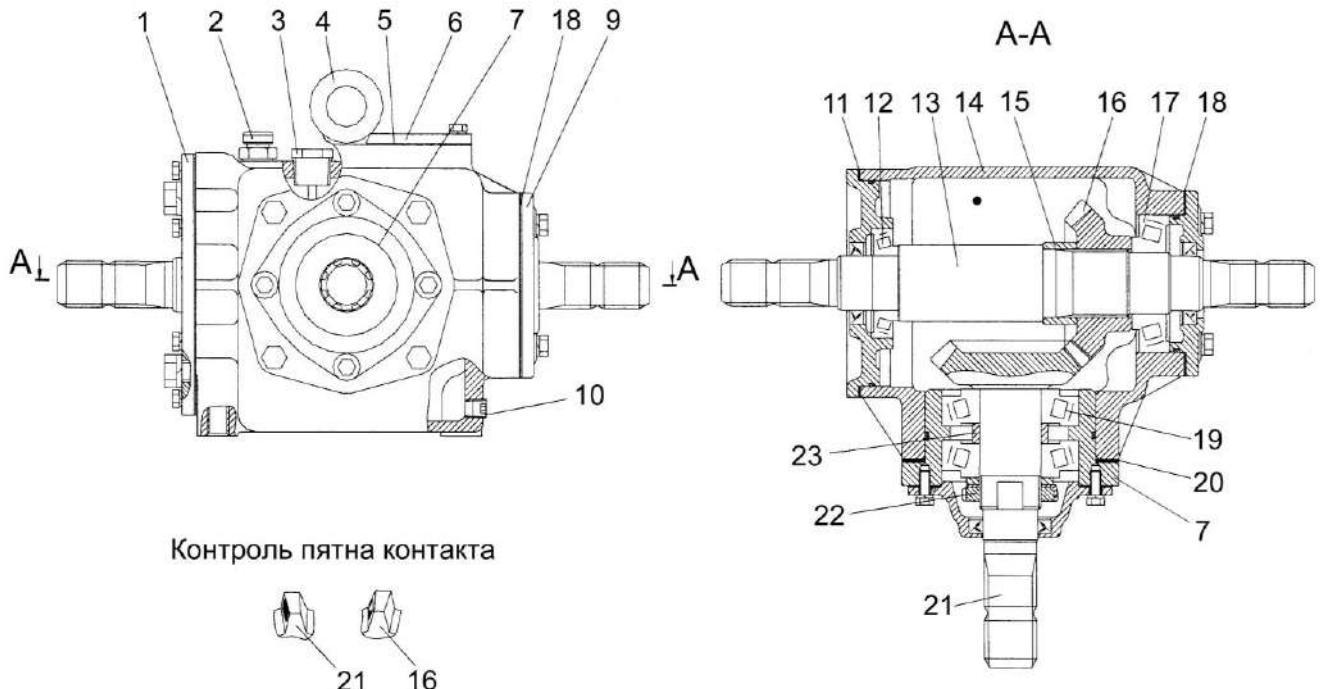
1, 6, 9 – крышки; 2 – сапун; 3 - маслоуказатель; 4 – рым-болт; 5, 11, 18, 20 – прокладки; 7 – стакан; 10 – пробка сливная; 12, 17, 19 – подшипники; 13 – вал; 14 – корпус; 15, 23 – втулки; 16 – шестерня; 21 – вал-шестерня; 22 – гайка со стопорной шайбой
