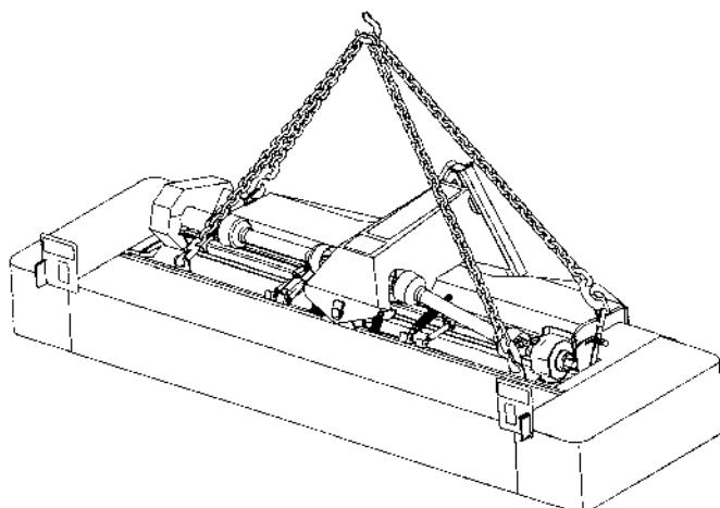
**Рисунок 13.1 – Схемы строповки косилки**
