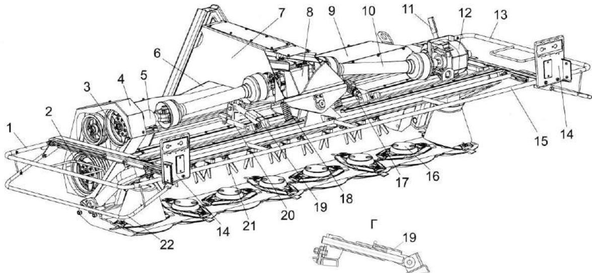
1, 13, 15 – рамки; 2, 3 – шкивы; 4 – ограждение; 5 – контрпривод; 6 – валкообразователь; 7 – рама навески; 8 – переходной редуктор; 9 – каркас; 10 – карданный вал; 11 – рычаг; 12 – конический редуктор; 14 – кронштейны; 16 – режущий брус; 17, 18 – пружины; 19 - фиксатор; 20 – амортизатор; 21 – бильное устройство; 22 – дуга
