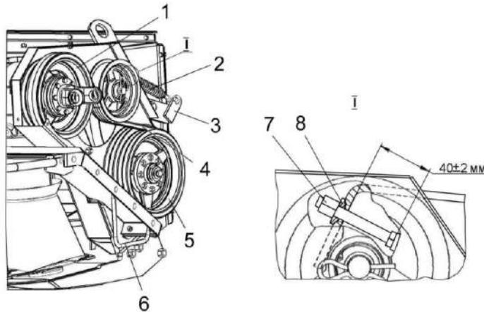
1, 5 – шкивы; 2 – пружина; 3 – натяжное устройство; 4 – ремень; 6 – дуга;
