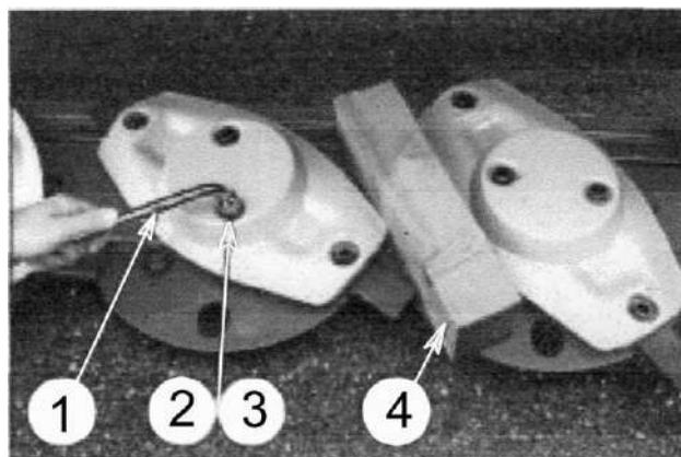
1 - торцевый гаечный ключ; 2 – болт; 3 – тарельчатая пружинная шайба; 4 - деревянный бруск
