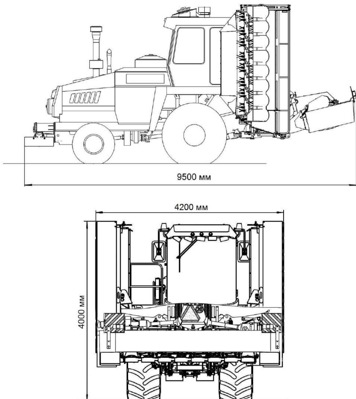
Рисунок 3.1 - Габаритные размеры косилки, в транспортном положении
