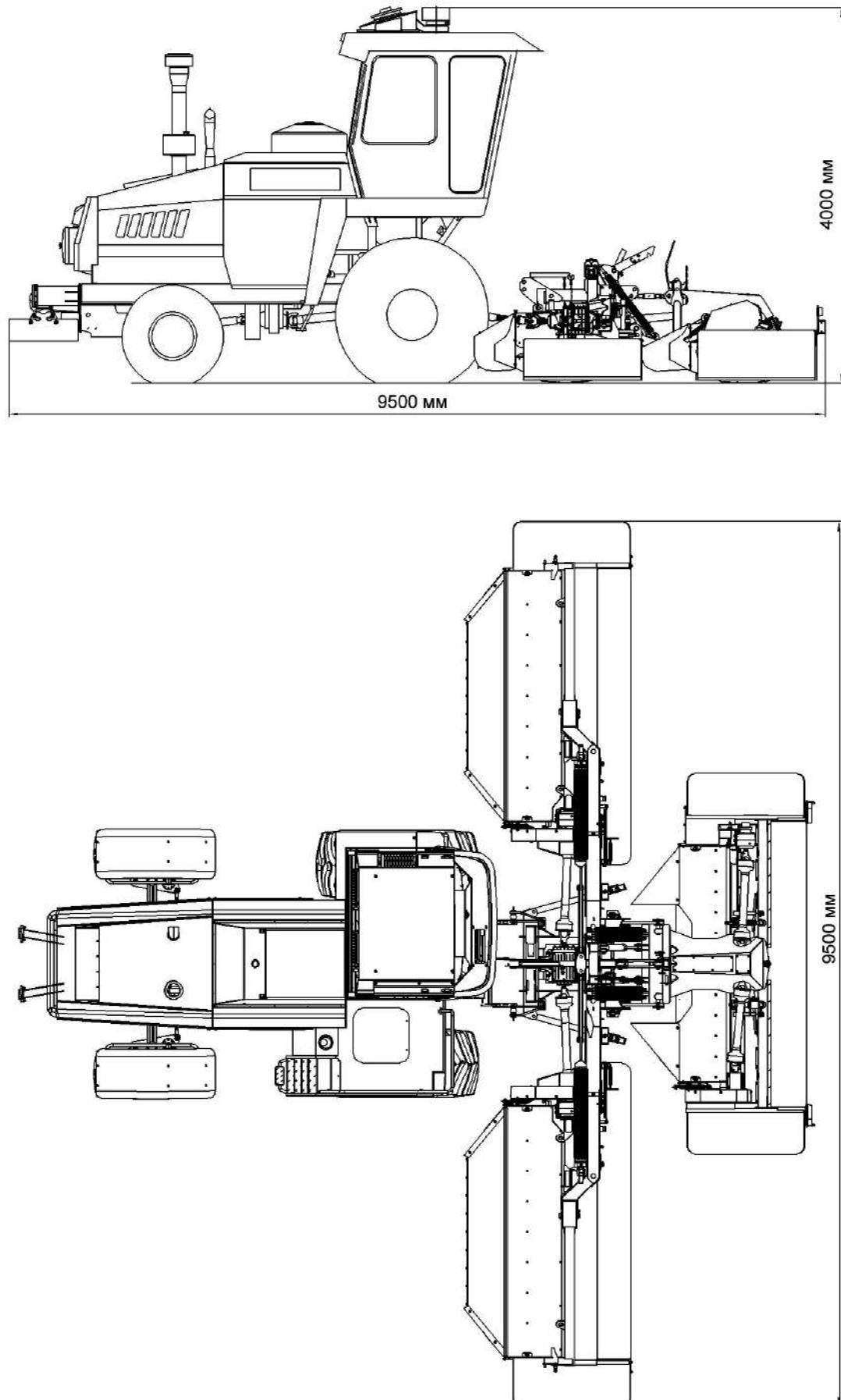
Рисунок 3.2 - Габаритные размеры косилки, в рабочем положении
