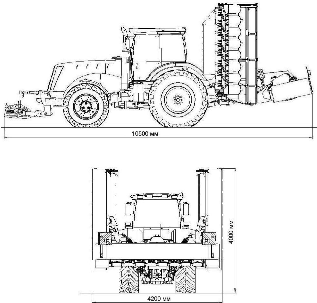
Рисунок 3.3 - Габаритные размеры косилки, в транспортном положении
