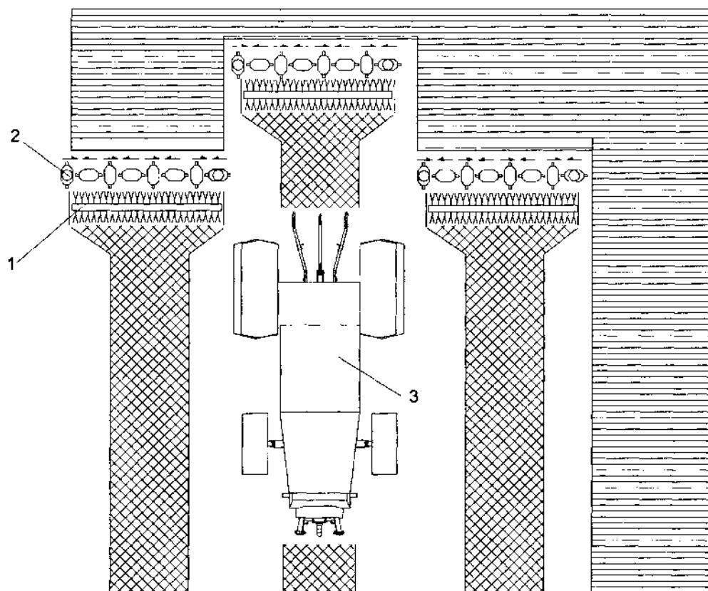
1 – бильное устройство; 2 - режущий брус; 3 – энергосредство
