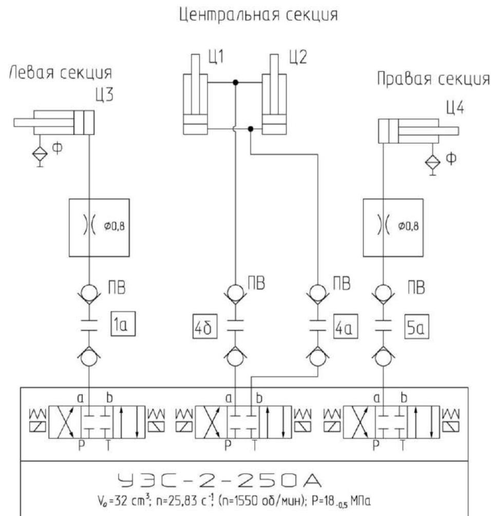
ПВ – полумуфта внутренняя; Ц1, Ц2 – гидроцилиндры подъема центральной секции; Ц3, Ц4 – гидроцилиндры складывания боковых секций; Ф – сапун
