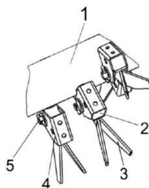
1 – вал; 2 – демпфер; 3 – бич; 4 – корпус; 5 – ось со шплинтом
