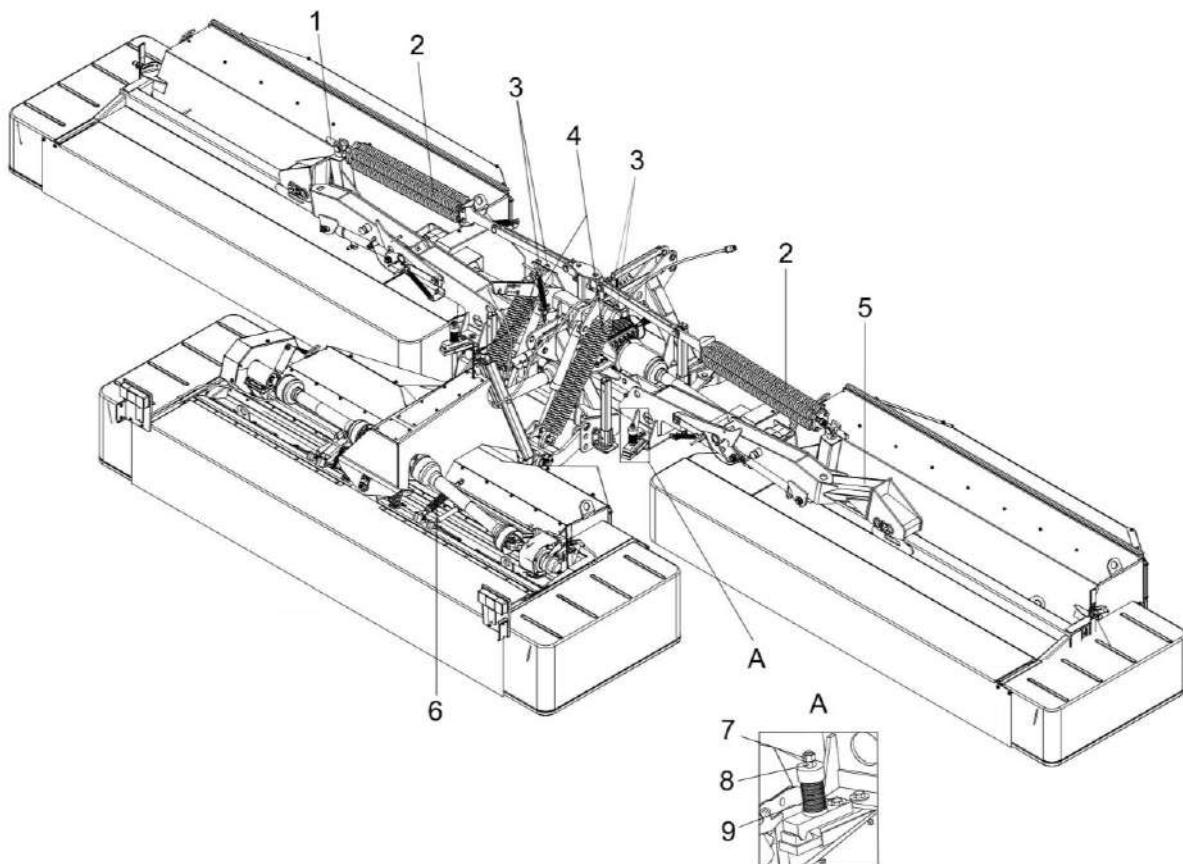
1, 3 – регулировочные винты; 2, 4, 6 – пружины; 5 – рычаг; 7 – контргайка; 8 – гайка; 9 – пакет тарельчатых пружин
