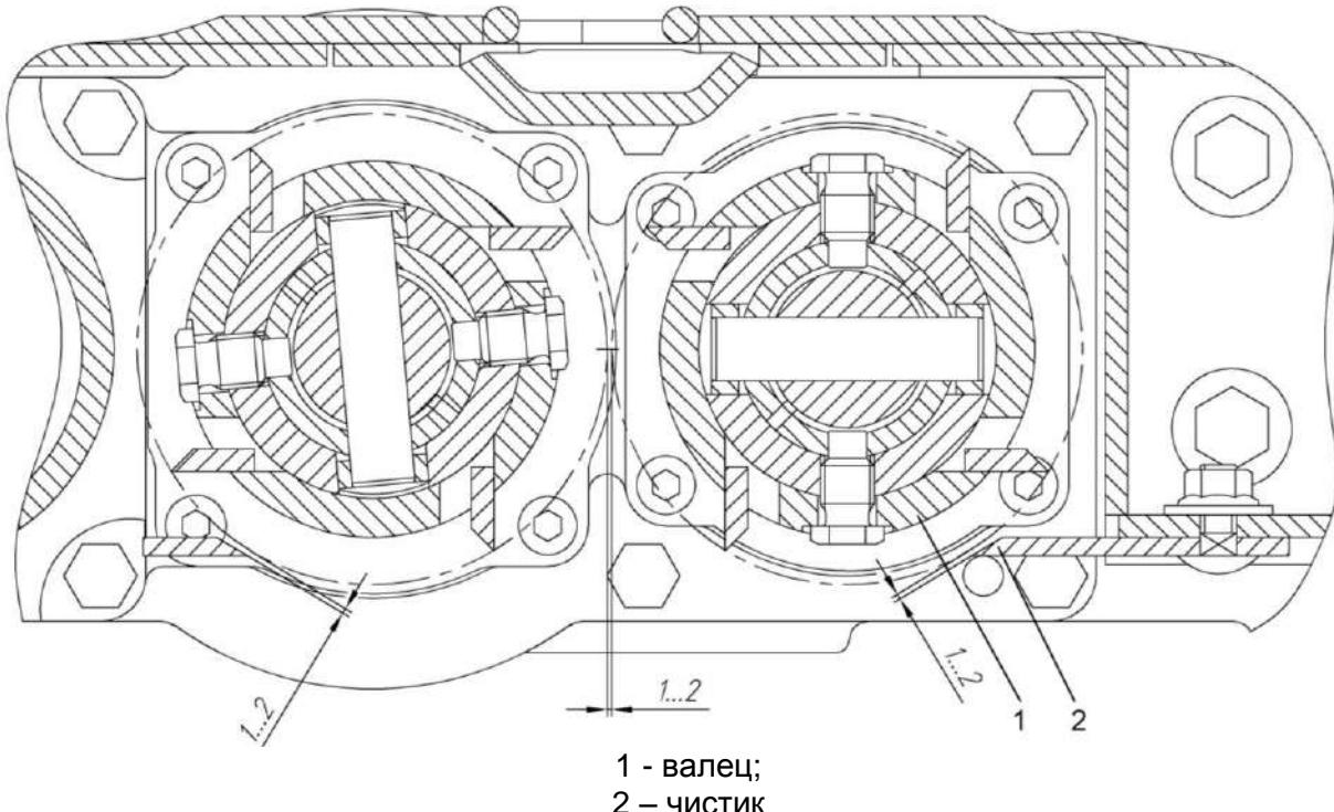
Рисунок 2.21 – Регулировка бичей вальцев и чистиков
