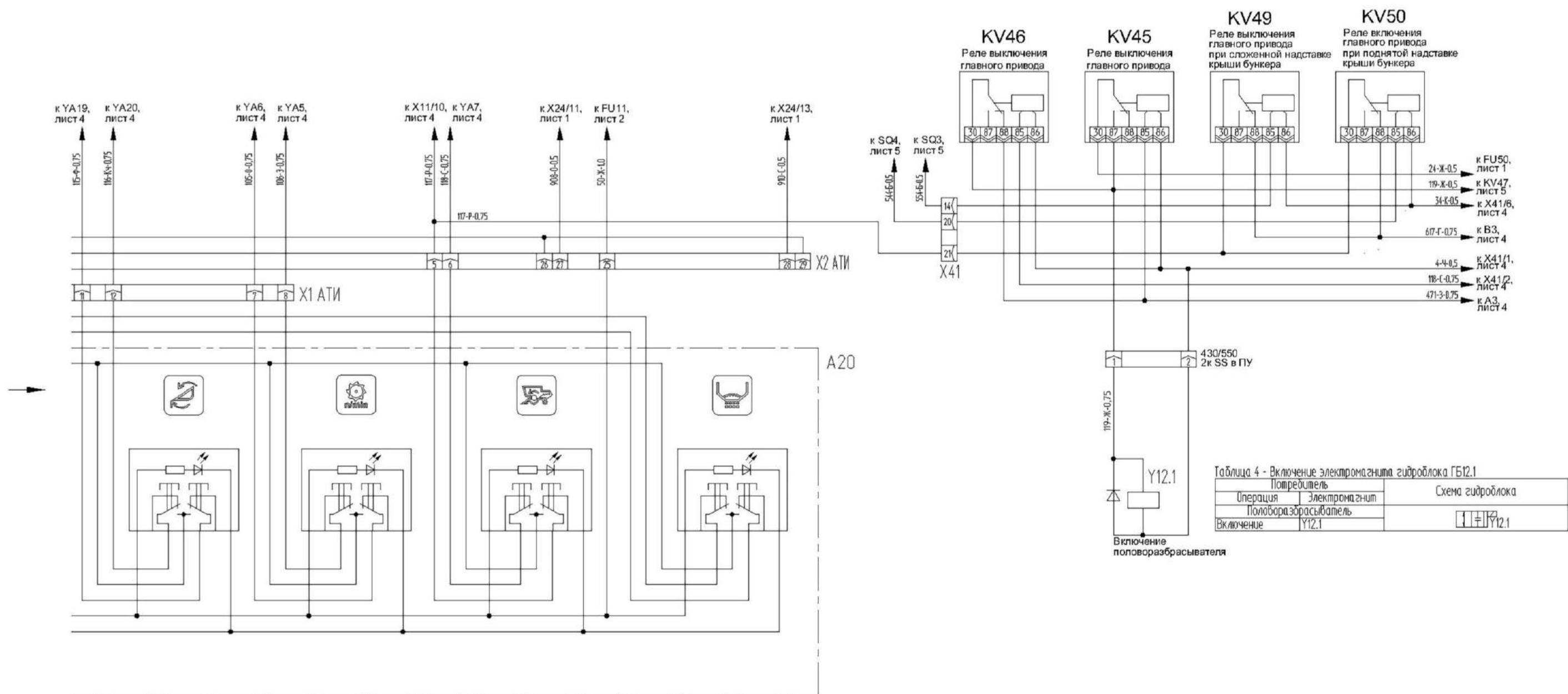
Рисунок Б.7 – Схема электрическая принципиальная комбайна (лист 7.2)
