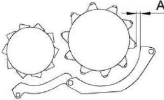
В точках С и D (рисунок 2.10) устанавливается параллельность барабана и подбарабанья в пределах  $\pm 2$  мм. Длина тяг G устанавливается равной 539 мм. Параллельность регулируется изменением длины одной из тяг G в пределах, необходимых для обеспечения требуемой параллельности.
