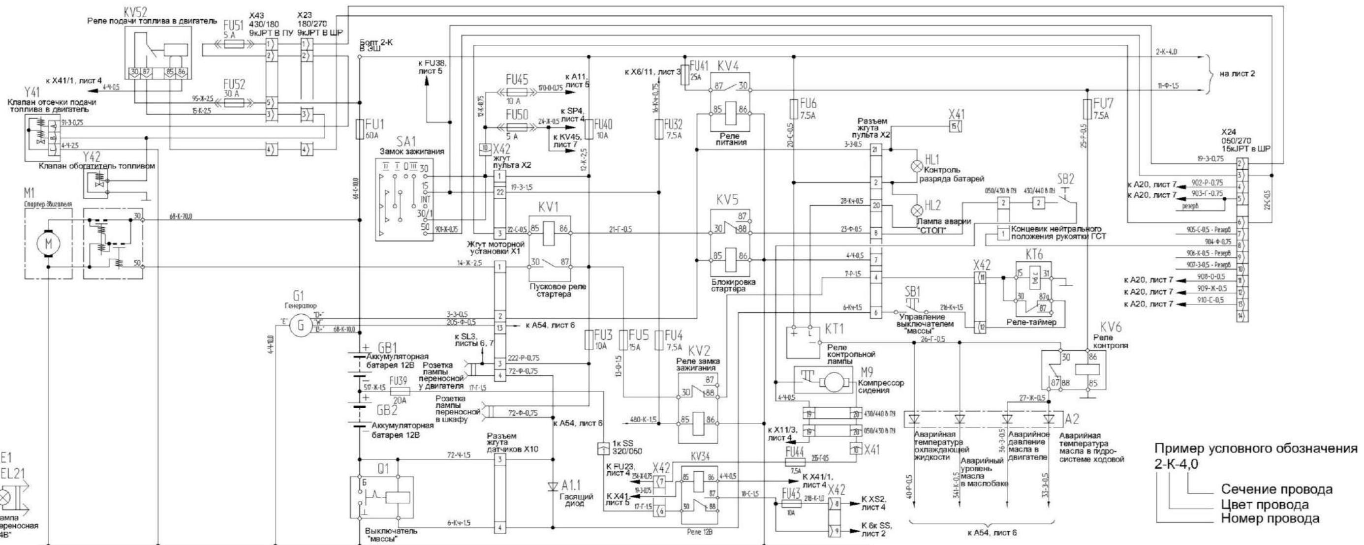
Рисунок Б.1 – Схема электрическая принципиальная комбайна (лист 1)
