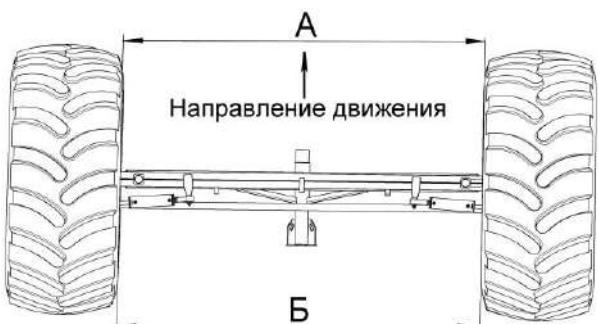
Рисунок 2.17 - Регулировка сходимости колес
