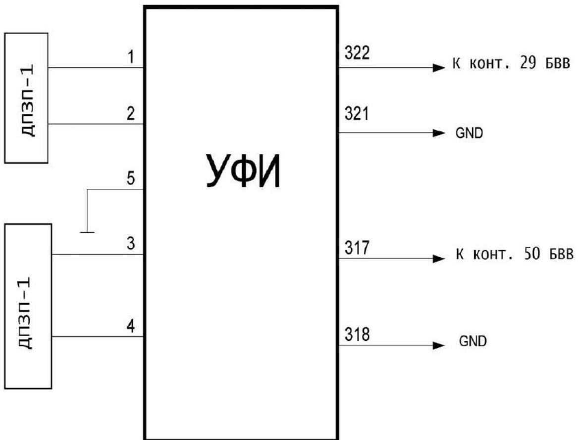
ДПЗП-1 – датчик потерь зерна пьезоэлектрический
