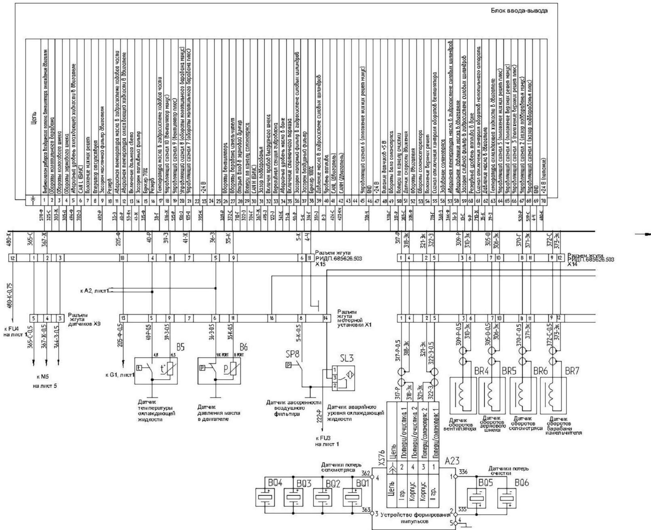
Рисунок Б.6 – Схема электрическая принципиальная комбайна (лист 6.1)
