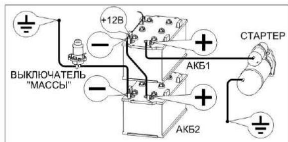
Рисунок 2.3 - Подключение аккумуляторных батарей
