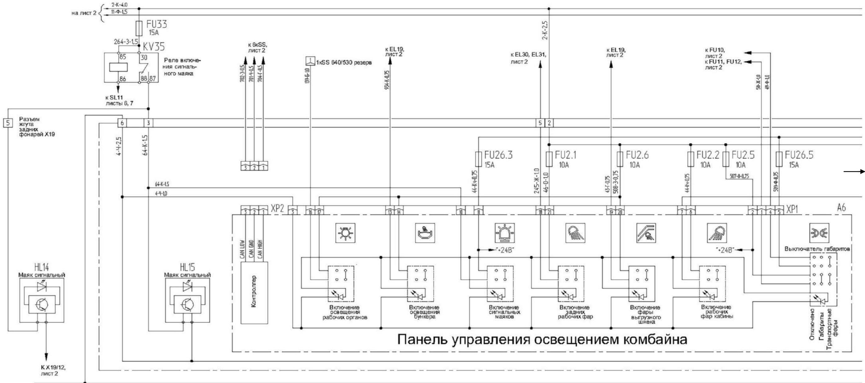
Рисунок Б.3 – Схема электрическая принципиальная комбайна (лист 3.1)
