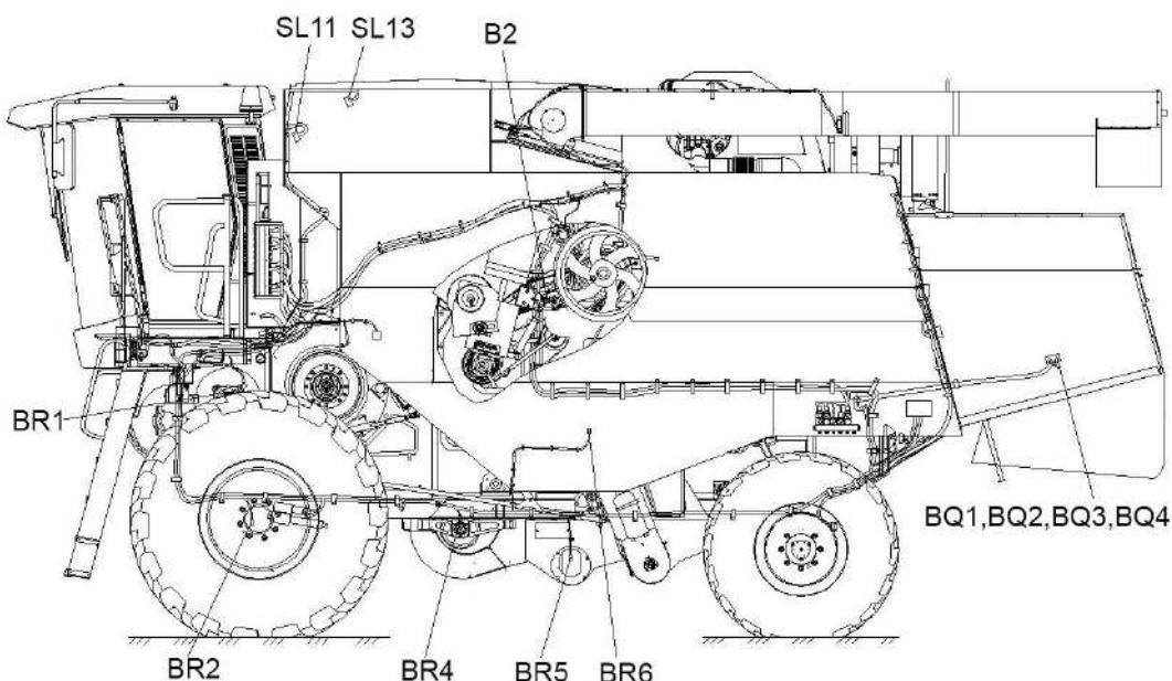
SL11 - датчик наполнения зернового бункера 100%; SL13 - датчик наполнения зернового бункера 70%; B2 – датчик сигнализации включенного привода выгрузки при сложенном выгрузном шнеке; BQ1, BQ2, BQ3, BQ4 - датчики контроля потерь соломотряса; BR6 – датчик оборотов соломотряса; BR5 – датчик оборотов зернового шнека; BR4 – датчик оборотов вентилятора очистки; BR2 – датчик скорости движения; BR1 – датчик оборотов молотильного барабана
