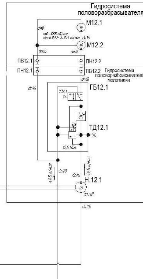
АТ – масляная секция радиатора; Б – бак масляный; ВК – вакуумметр; ГБ12.1 – гидроблок; ДТ – датчик указателя температуры жидкости; М12.1, М12.2 – гидромоторы; Н12.1 – гидронасос; ПВ12.1, ПВ12.2 – полумуфта внутренняя; ПН12.1, ПН12.2 – полумуфта наружная; ТД12.1 – точка диагностическая; Ф1.1 – фильтр
