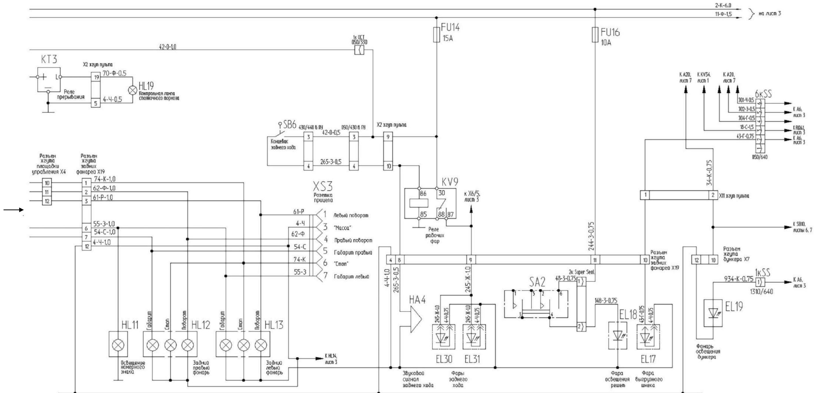
Рисунок Б.2 – Схема электрическая принципиальная комбайна (лист 2.2)
