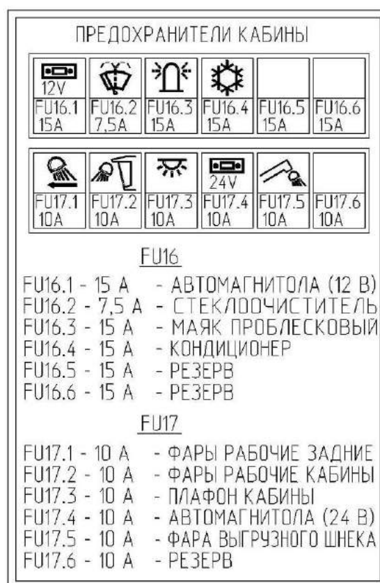
Рисунок 1.42 – Схема расположения предохранителей
