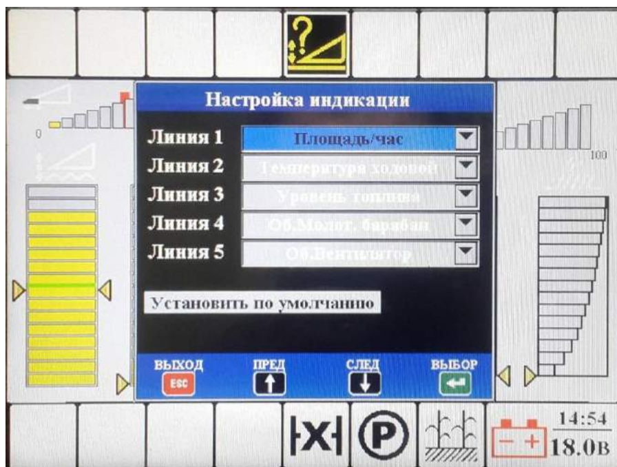
Рисунок Ж. 24– Вид окна «Настройки индикации»
