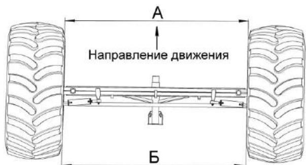
Рисунок 2.25 - Регулировка сходимости колес
