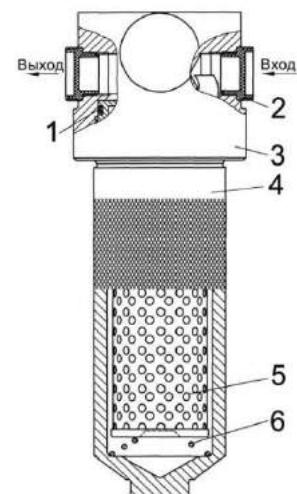
1 – кольцо уплотнительное; 2 – заглушка транспортная; 3 – головка фильтра; 4 – стакан; 5 - фильтроэлемент; 6 – пружина
