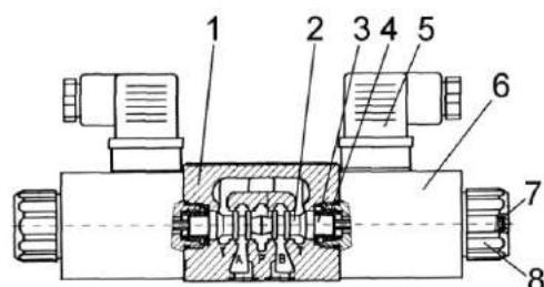
А, В – цилиндрические отводы; Р – подвод рабочей жидкости; Т – слив рабочей жидкости
