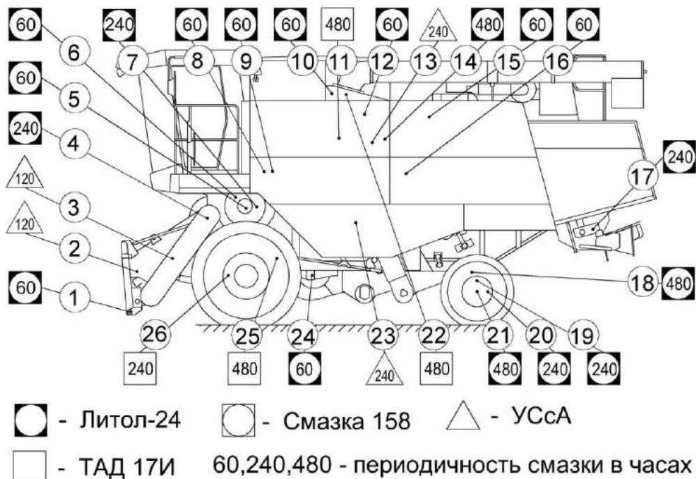
Рисунок 3.1 – Схема смазки молотилки самоходной (вид слева)
