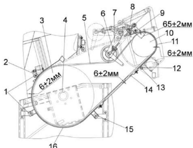
1, 9, 15 – уголки; 2 – кронштейн; 3, 10 – шкивы; 4 – шайба регулировочная; 5 – ремень; 6 – гайка; 7 – рычаг; 8 – пружина; 12 – втулка; 11, 14, 16 – щитки; 13 – болт
