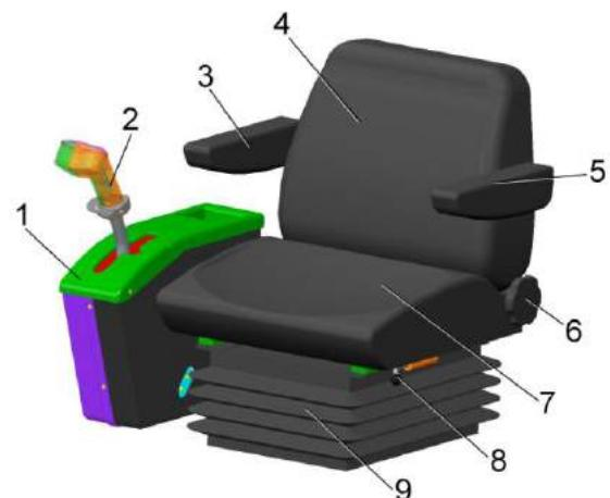
1 – блок управления; 2 - рукоятка управления скоростью движения; 3, 5 – подлокотники; 4 – спинка; – подушка сиденья; 6 – рычаг фиксации наклона спинки; 7 – подушка; 8 - рычаг фиксации продольного перемещения; 9 – чехол
