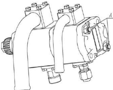
Рисунок 4.1 – Демонтаж гидронасоса
