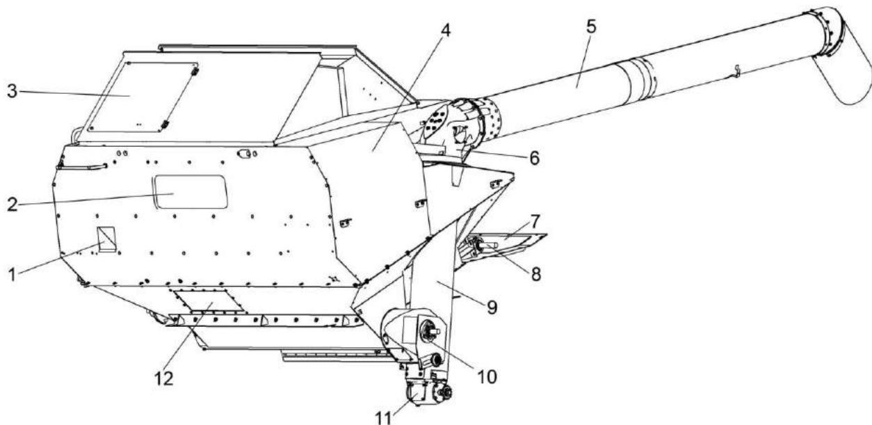
1 – окно пробоотборника; 2 – смотровое окно; 3 – крыша бункера; 4 - бункер; 5 – поворотный выгрузной шнек; 6 – отвод с редуктором; 7 - настил; 8 - вибрордно; 9 – шнек наклонный; 10 - шнек горизонтальный; 11 - редуктор; 12 – крышка
