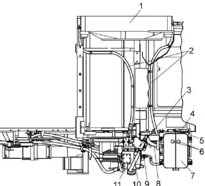
1 – блок радиаторов масляный; 2, 14 – рукава; 3 – фильтр всасывающий; 4 - маслоуказатель; 5 – датчик сигнализатора температуры; 6 – сапуны; 7 – бак масляный; 8, 10 – рукава всасывающие; 9 – датчик указателя температуры; 11 – насос аксиально–поршневой; 12 – гидромотор аксиально–поршневой нерегулируемый; 13 – рукава высокого давления; 15 – полумуфта заправочная
