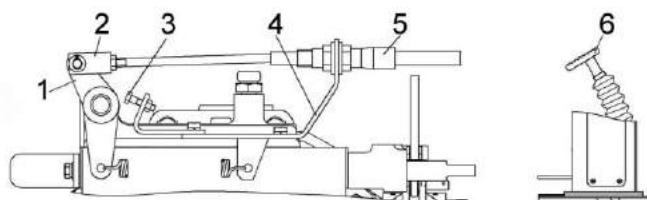
1 – рычаг; 2 – вилка; 3 – болт; 4 – кронштейн; 5 – трос; 6 – педаль блокировки коробки передач
