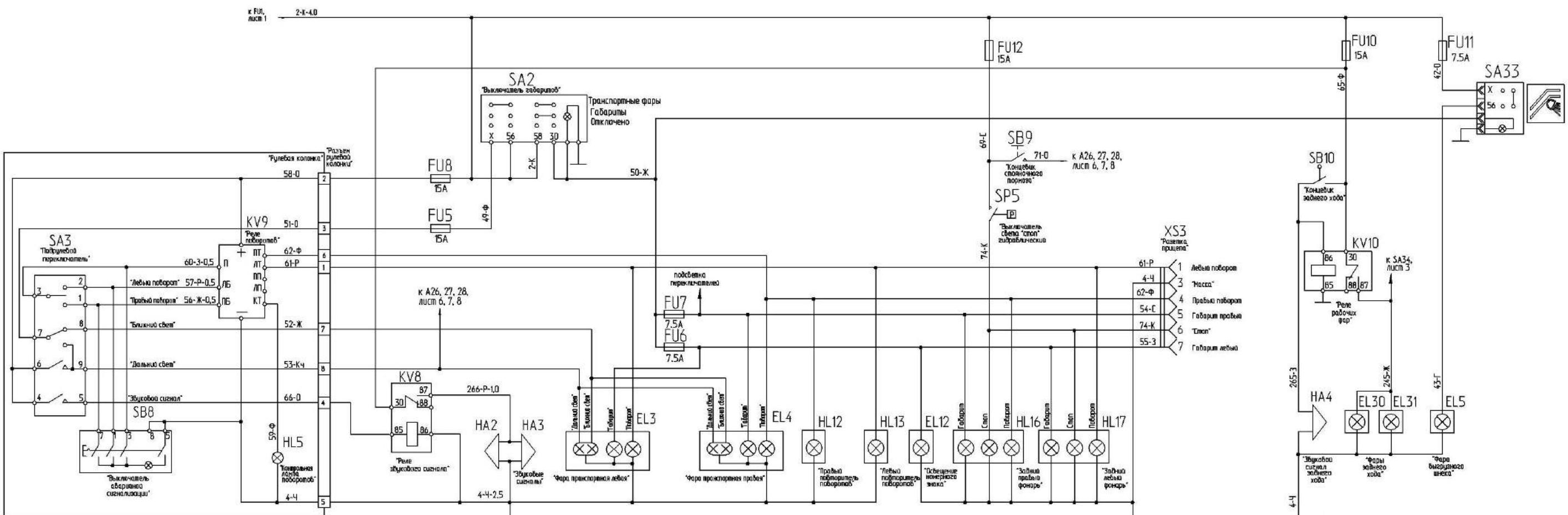
Рисунок Б.2 – Схема электрическая принципиальная комбайна (лист 2)
