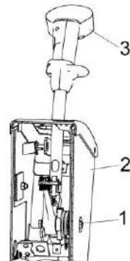
1 – регулировочный болт; 2 – блок управления; 3 – рукоятка управления скоростью движения
