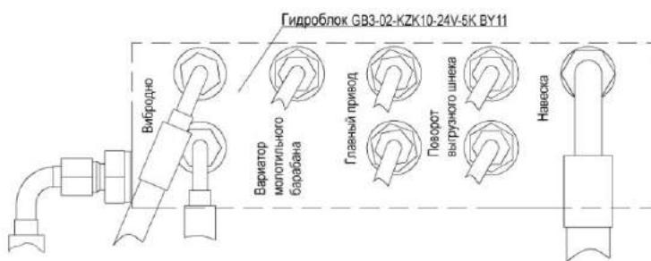
Рисунок 1.25 - Установка гидроблока пятисекционного ГБ3
