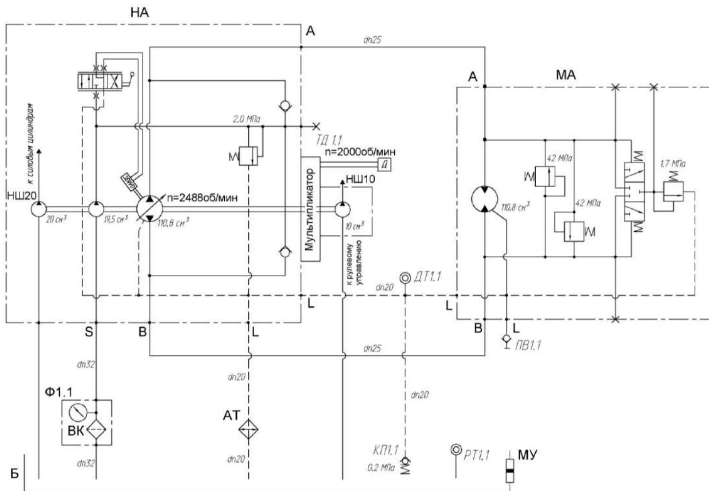
АТ - масляная секция радиатора; Б - бак масляный; ВК – вакуумметр; КП1.1 – гидроклапан обратный; МУ – указатель уровня масла; МА – гидромотор аксиально-поршневой нерегулируемый; НА – тандем насосов; ПВ1.1 – полумуфта внутренняя; ДТ1.1 – датчик ДУТЖ-01; РТ1.1 – датчик аварийной температуры жидкости; ТД1.1 – соединение резьбовое с колпачком; Ф1.1 – фильтр всасывающий
