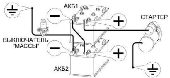
Рисунок 2.2 - Подключение аккумуляторных батарей
