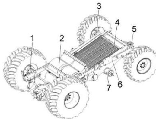
1 – мост ведущих колес; 2 – вентилятор; 3 – мост управляемых колес; 4 – стан решетный нижний; 5 – тяговое устройство; 6 – рама; 7 – блок шнеков
