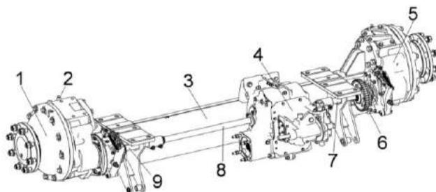
1, 5 – бортовые редукторы; 2 – сапун; 3 – балка; 4 – коробка передач; 6 - муфта; 7, 8, 9 – полуоси
