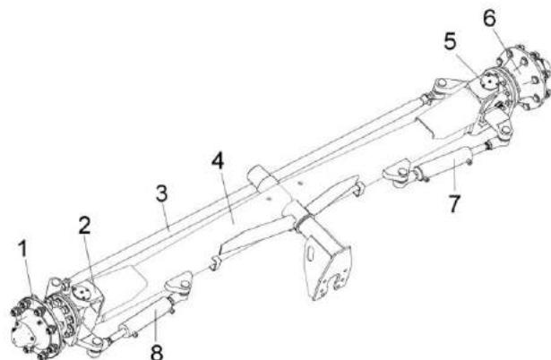
1, 6 – ступицы; 2, 5 - поворотный кулак; 3 – тяга рулевая; 4 – балка; 7, 8 – гидроцилиндры;
