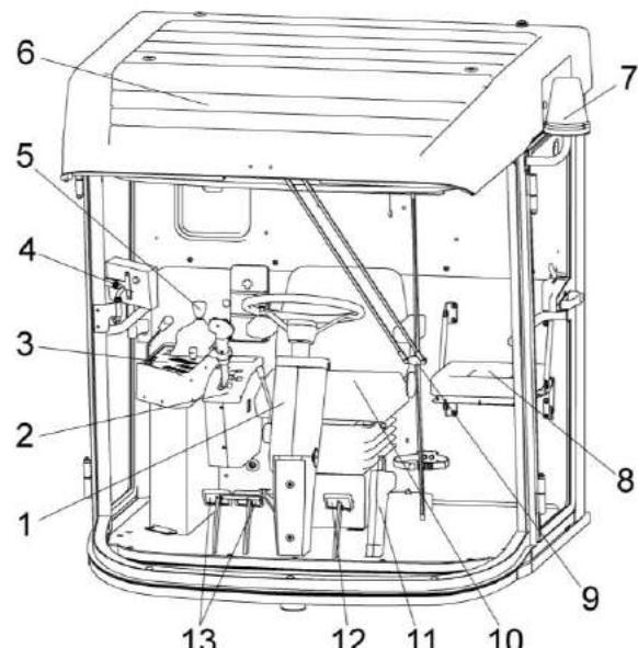
1 – колонка рулевая; 2 – блок управления; 3 – пульт управления; 4 – бортовой компьютер; 5 – рычаг переключения передач; 6 - кабина; 7 – маяк проблесковый; 8 - дополнительное сиденье; 9 – стеклоочиститель; 10 - сиденье; 11 – рукоятка стояночного тормоза; 12 – педаль блокировки коробки передач; 13 - тормозные педали
