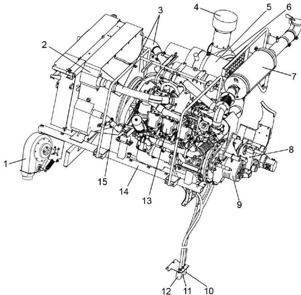
1 – пылесос; 2 – радиатор; 3 – трубы воздушные; 4 – воздухозаборник вращающийся; 5 – бачок расширительный; 6 – воздухоочиститель; 7 - глушитель; 8 – установка гидронасосов; 9 – главный привод; 10 – сливной рукав охлаждающей жидкости; 11 – сливной рукав масла из мультиплексора; 12 - сливной рукав масла из картера двигателя; 13 – двигатель; 14 – рама подмоторная; 15 - труба водяная
