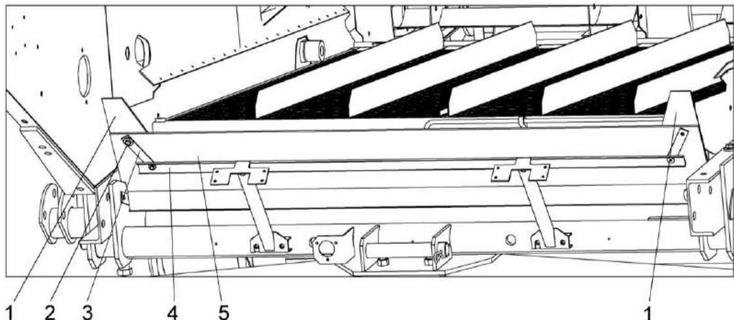
1 - дополнительные щитки; 2 - детали крепления; 3, 4 - планки; 5 - щиток
