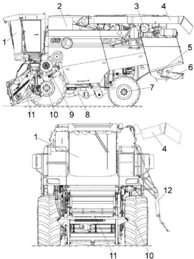
1 - кабина; 2 – бункер зерновой; 3 - установка двигателя; 4 – шnek выгрузной; 5 - соломоизмельчитель; 6 - дефлектор; 7 – мост управляемых колес; 8 - очистка; 9 – молотильный аппарат; 10 – мост ведущих колес; 11 – наклонная камера; 12 – трап
