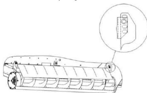
Рисунок 2.20 – Регулировка ограждения над горизонтальным шнеком бункера
