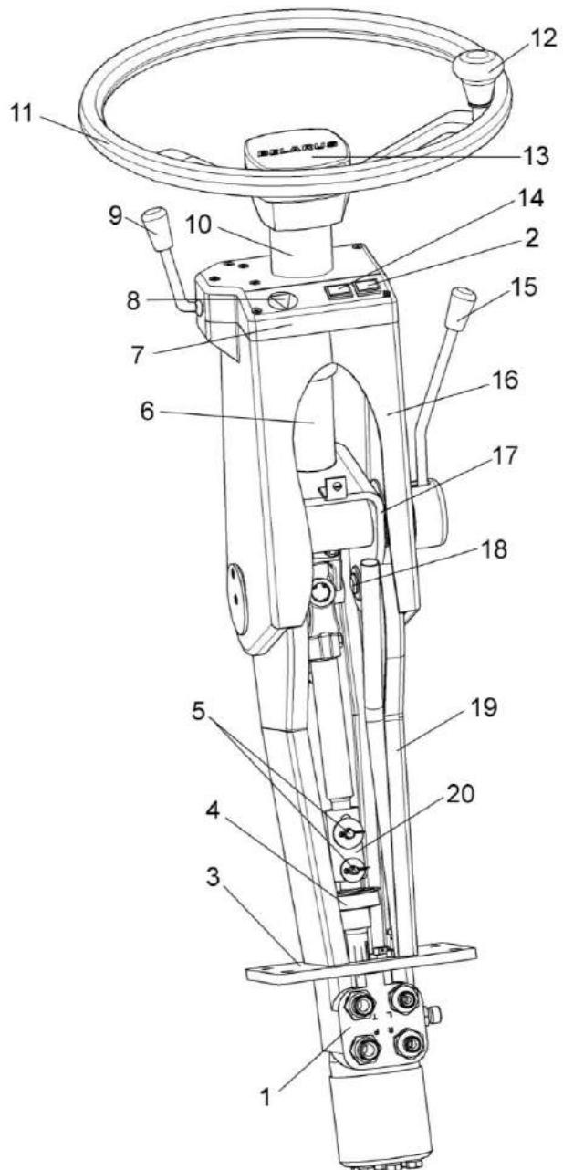
1 - насос дозатор; 2 - контрольная лампа дальнего света; 3, 17 – кронштейны; 4 – опора; 5, 18 – оси; 6 – вал рулевой; 7 – крышка; 8 – выключение аварийной сигнализации; 9 – подрулевой переключатель; 10 – колпак; 11 – колесо рулевое; 12 – ручка; 13 – крышка; 14 - контрольная лампа указателей поворотов; 15 - рукоятка фиксации угла наклона колонки; 16 - кожух; 19 – стойка; 20 – втулка
