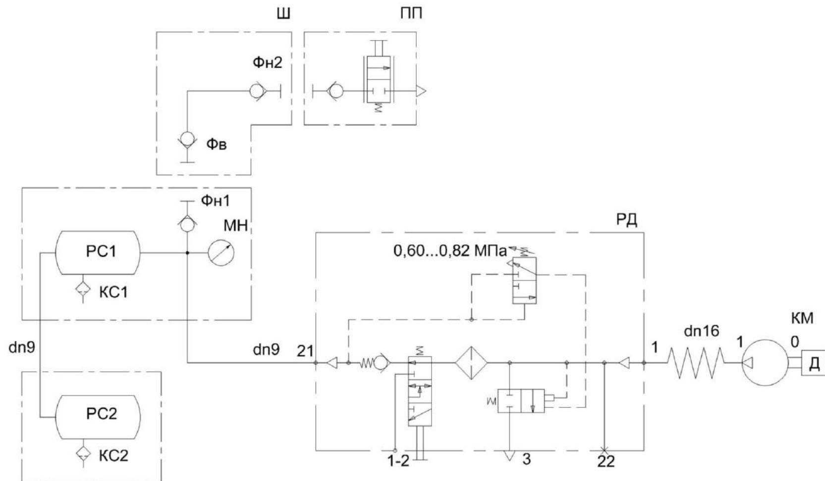
КМ – компрессор; КС1, КС2 – краны слива конденсата; МН - манометр; ПП – пневмопистолет обдувочный; РД – регулятор давления; РС1, РС2 - ресиверы; Фв, Фн1, Фн2 - фитинги; Ш – шланг
