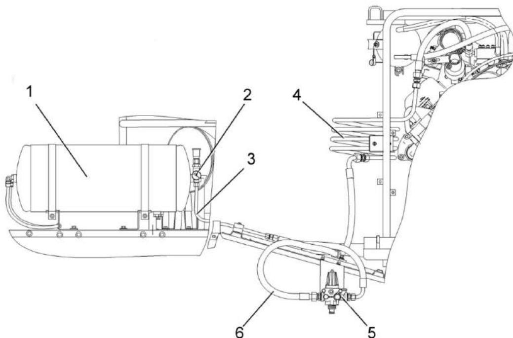
1 – ресивер; 2 - манометр; 3, 4 - трубопроводы; 5 – регулятор давления; 6 –рукав высокого давления
