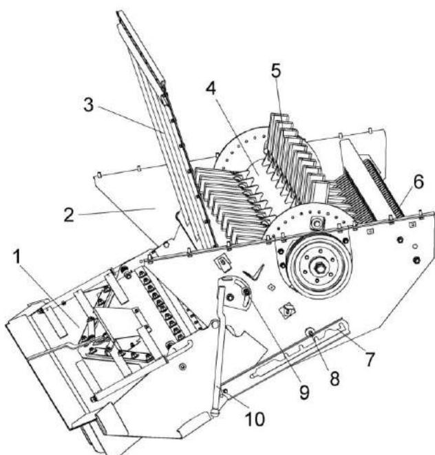
1 – дефлектор; 2 – корпус измельчителя; 3 – заслонка; 4 – ротор измельчителя; 5 – нож; 6 – ножевая опора; 7 – полоз; 8, 9 – гайки; 10 - рукоятка сектора
