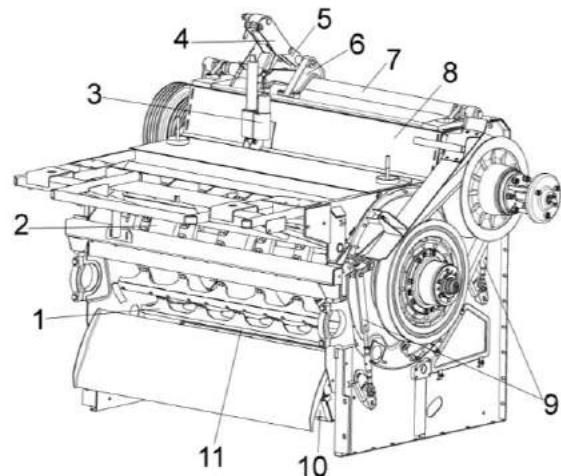
1 – бич; 2 – барабан молотильный; 3 – электромеханизм подбарабанья; 4 – кронштейн; 5 – рычаг; 6 – опора; 7 – вал торсиона; 8 – битер отбойный; 9 – подвески подбарабанья; 10 - камнеуловитель; 11 – подбарабанье
