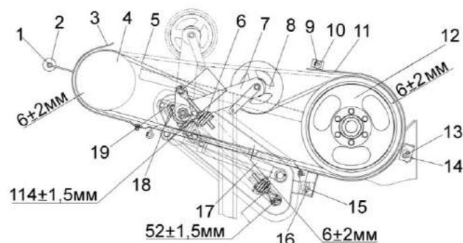
1, 9, 13, 15 – болты; 2, 10, 14, 16 – шайбы; 3, 11 – щитки; 4, 12 – шкивы; 5 – ремень; 6 – пружина; 7 – рычаг; 8 – ролик натяжной; 17 – гидроцилиндр; 18 – гайка; 19 - опора
