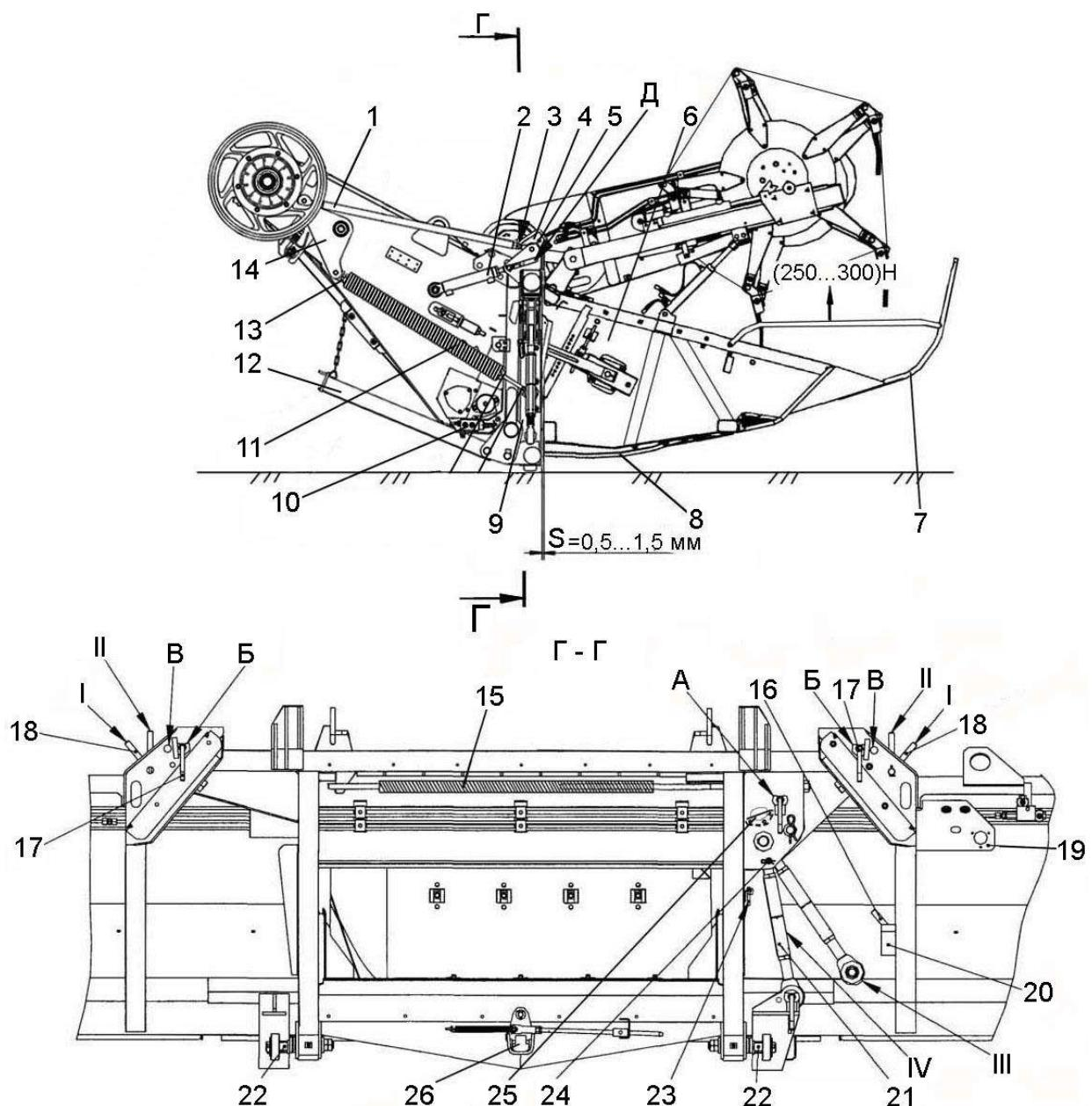
1 – регулируемая тяга; 2, 10 - гидроцилиндр; 3 – серьга; 4, 14, 19, 23 – кронштейны; 5 – ось; 6 – жатка; 7 – прутковый делитель; 8 – башмак; 9 – переходная рамка наклонной камеры; 11, 15 – блоки пружин; 12 - упор; 13 - винт; 16, 17 – пальцы-фиксаторы; 18 – рукоятка упора; 20 – втулка; 21 – толкатель; 22 - эксцентрик; 24 – ось со шплинтом; 25 - рычаг двуплечий; 26 – фиксатор; Д – паз
