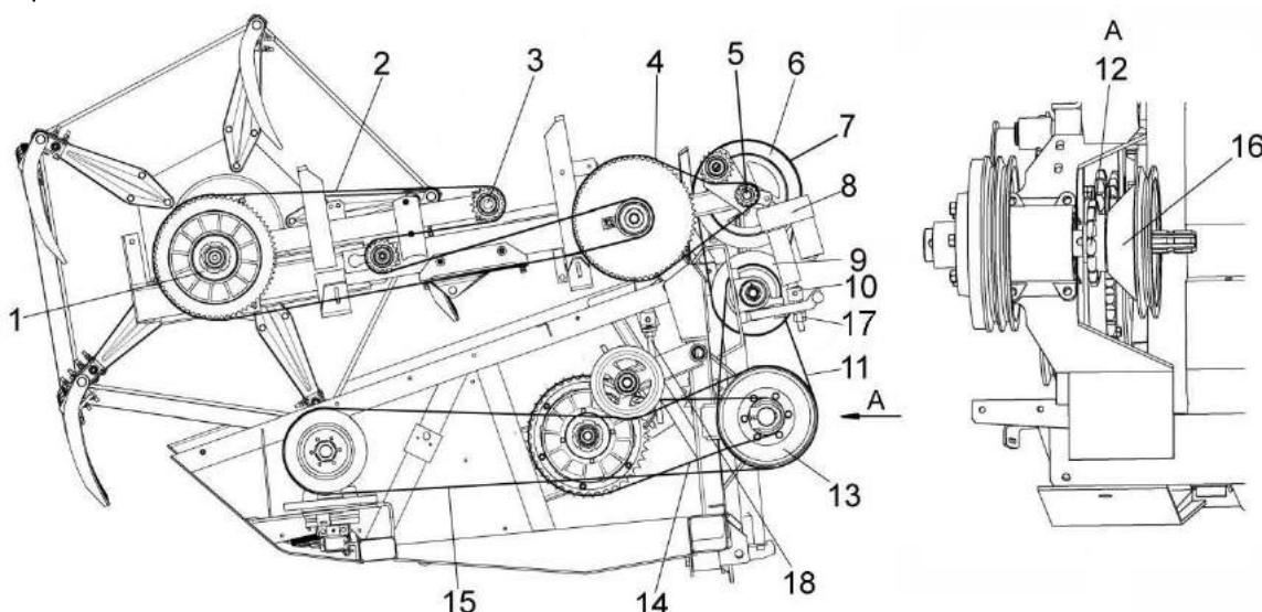
1 – муфта фрикционная; 2, 4, 14 – цепные передачи; 3, 5 – звездочки; 6, 13, 16 - шкивы; 7, 11, 15 – ременные передачи; 8 – исполнительный электромеханизм; 9 - вариатор; 10 – скоба; 12 – звездочка контрапривода; 17 – гайка; 18 - стяжка
