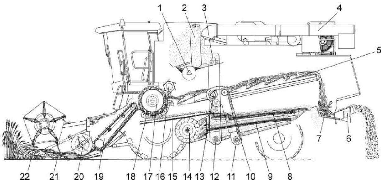
1 – шнек горизонтальный; 2 – шнек загрузной зерновой; 3 – элеватор зерновой; 4 - шнек выгрузной; 5 – соломотряс; 6 – дефлектор; 7 – соломоизмельчитель; 8 – верхний решетный стан; 9 – нижний решетный стан; 10 – элеватор колосовой; 11 – шнек колосовой; 12 – шнек зерновой; 13 - домолачивающее устройство; 14 – вентилятор; 15 – стрясная доска; 16 – отбойный битер; 17 – барабан молотильный; 18 – подбарабанье; 19 – транспортер наклонной камеры; 20 – шнек; 21 – режущий аппарат; 22 – мотовило
