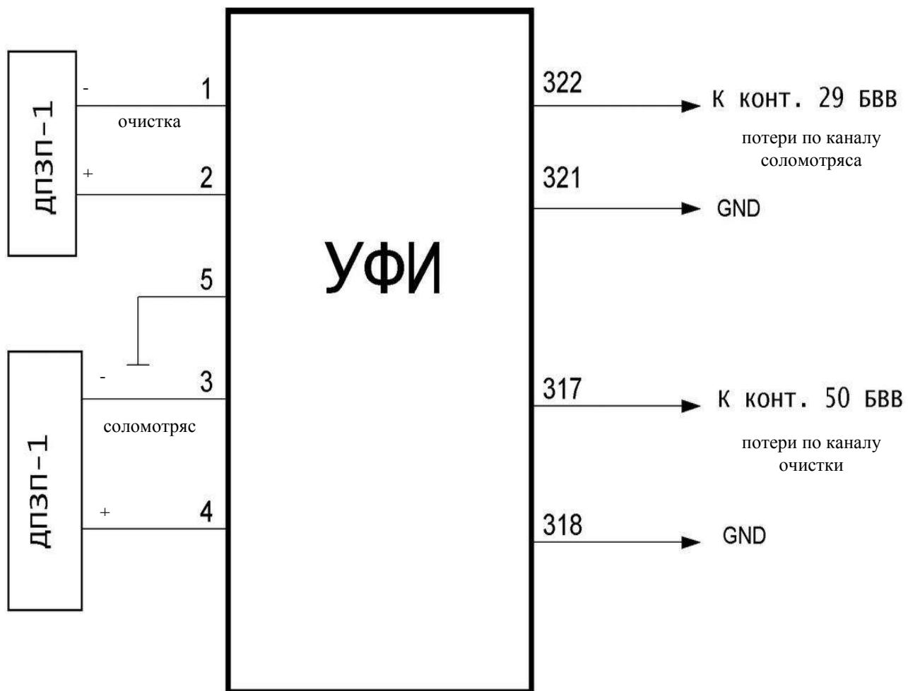
ДПЗП-1 – датчик потерь зерна пьезоэлектрический
