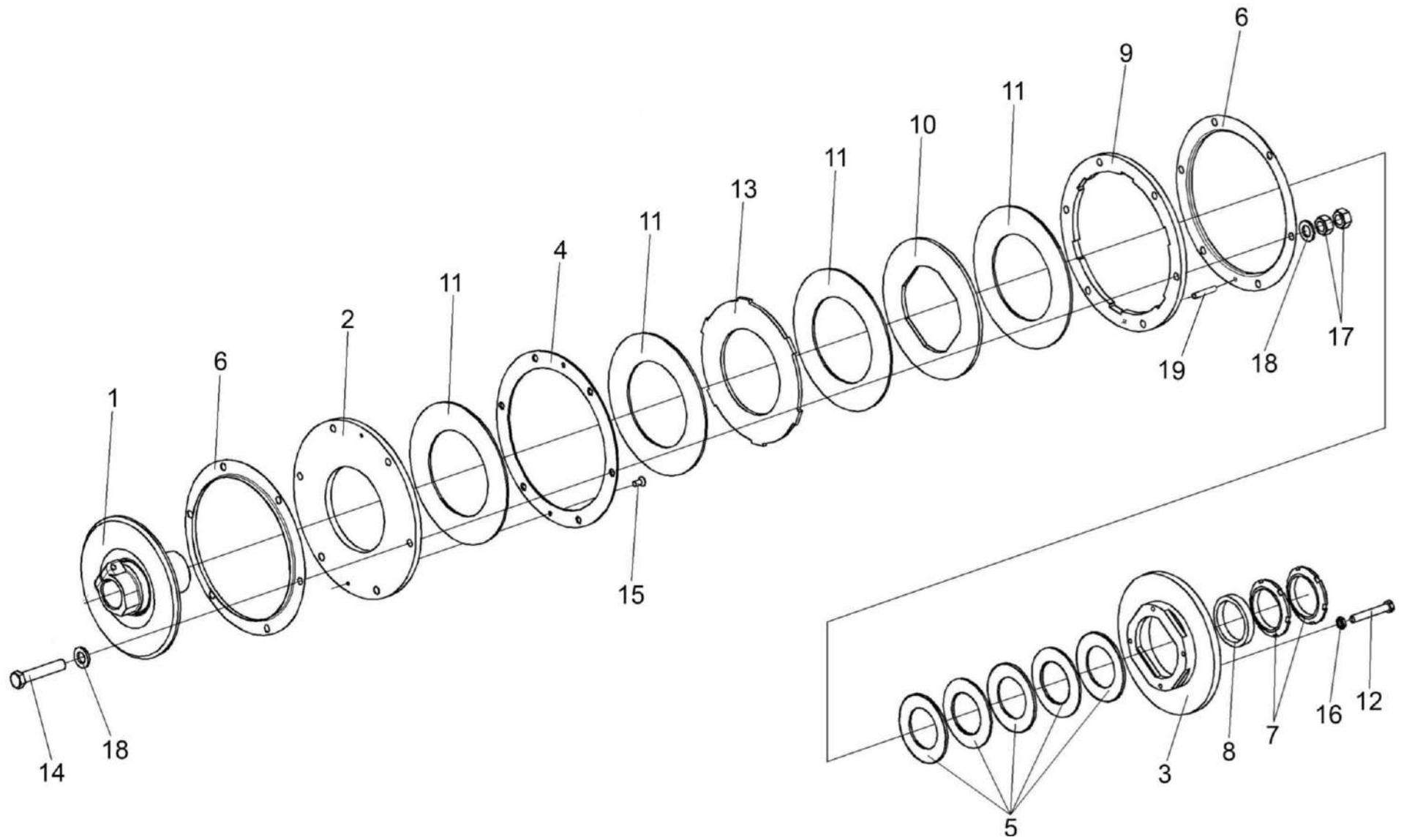
Рисунок 12 – Муфта предохранительная КЗК-12-1-0502100
