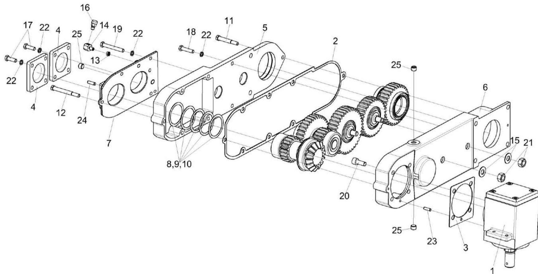
Рисунок 43 – Мультипликатор КПС-4-0517100-01 (корпуса, крышки)
