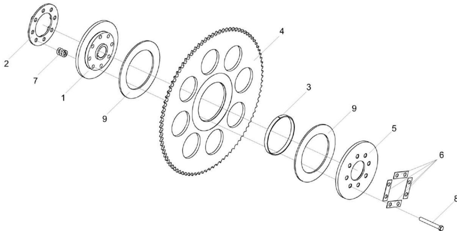
Рисунок 49 – Муфта предохранительная КПС-5-0502040
