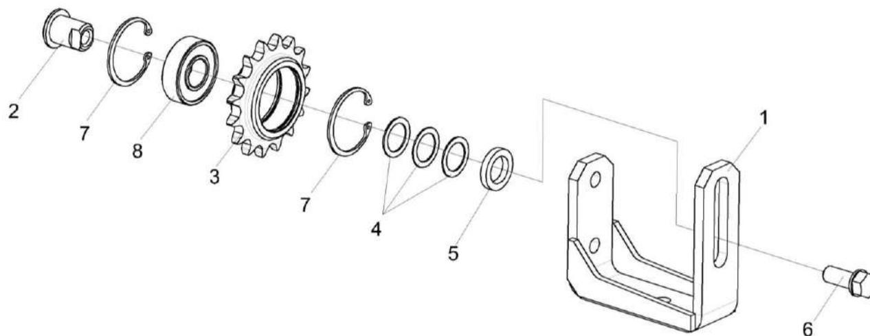
Рисунок 47 – Устройство натяжное КПС-4-0523000
