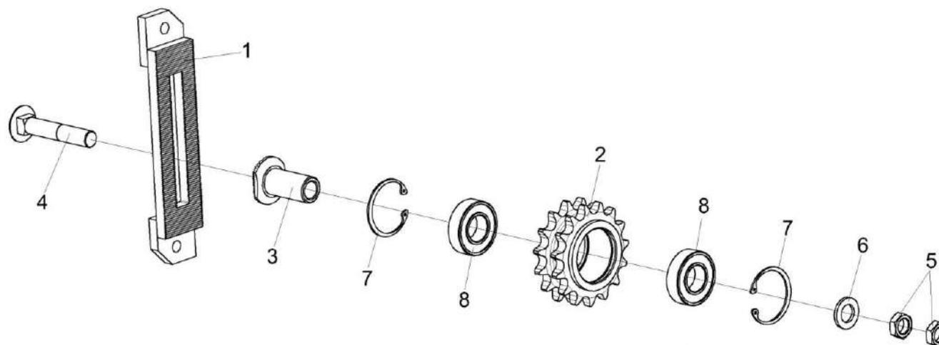
Рисунок 46 – Устройство натяжное КП-6-0524000
