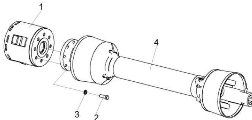
Рисунок 54 – Вал карданный телескопический КЗК 0500250-01
