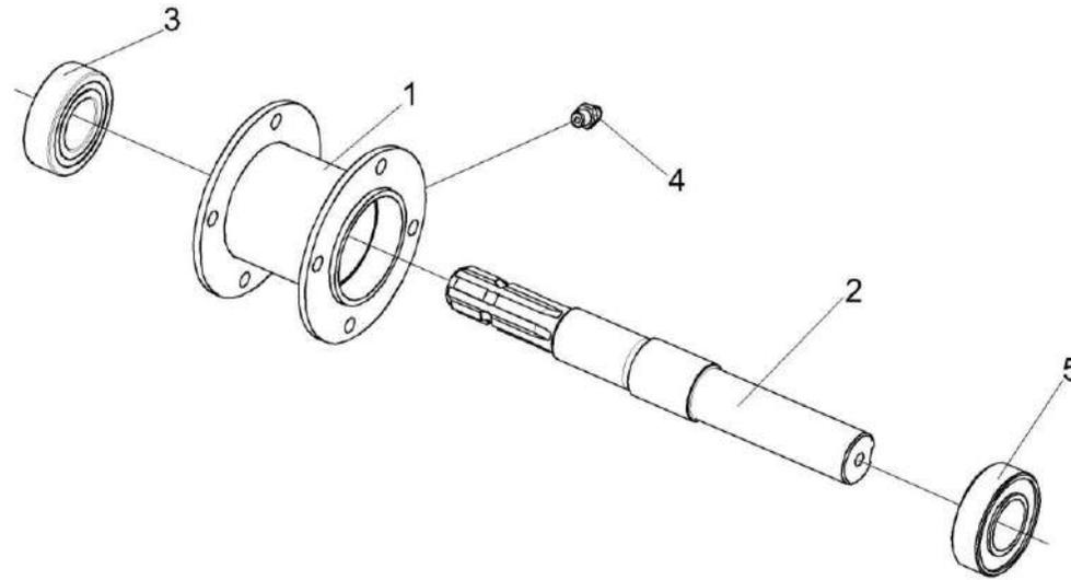
Рисунок 50 – Контрпривод 1.320.193
