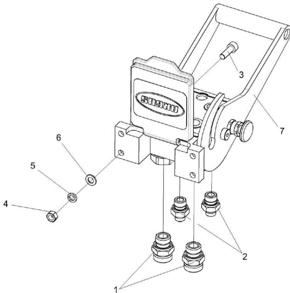
Рисунок 56 – Разъем гидравлический многофункциональный КЗК-1420-0689390
