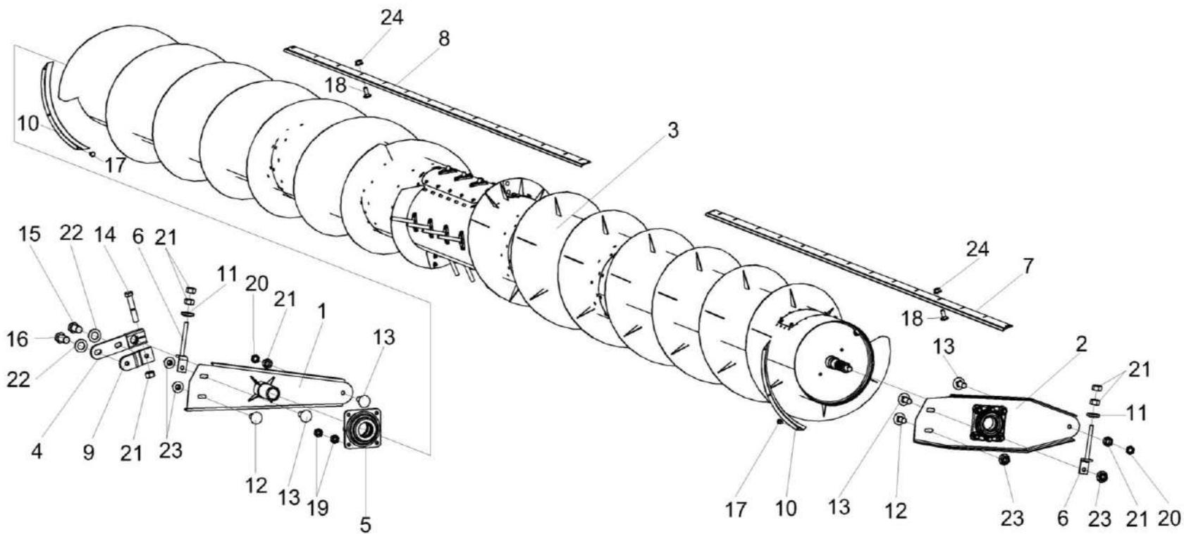
Рисунок 4 – Установка шнека КЗК-1492-2502000
