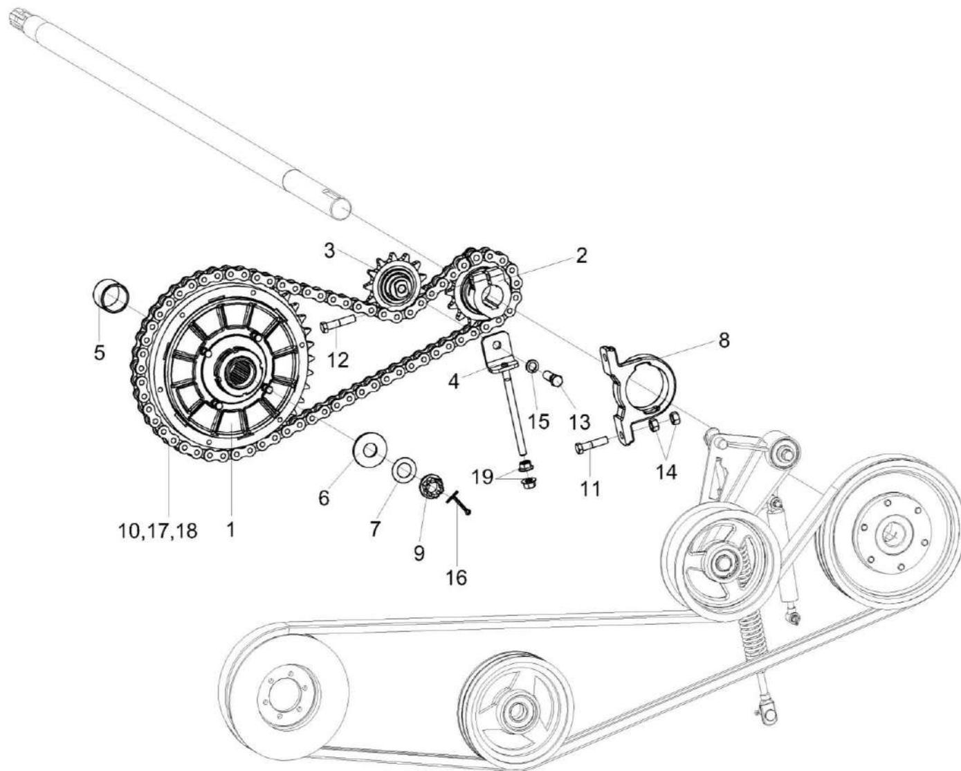
Рисунок 19 – Установка приводов КЗК-1492-2504000 (лист 3)
