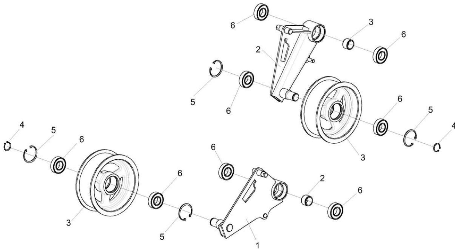
Рисунок 26 – Устройство натяжное КЗК-9-1-2512000А и КЗК-9-1-2512000А-01
