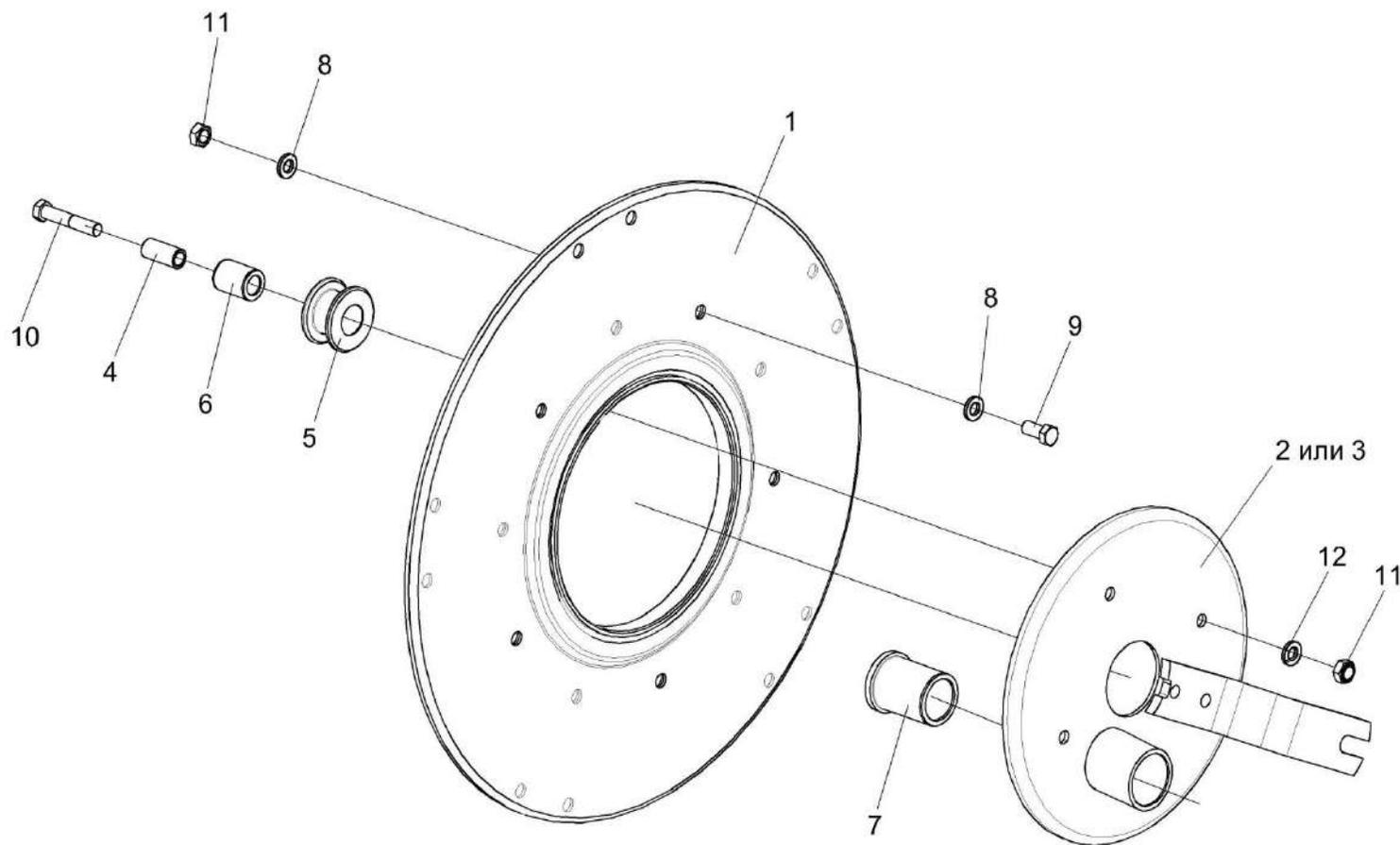
Рисунок 16 – Эксцентрик КЗК-1420-1573170 и КЗК-1420-1573180
