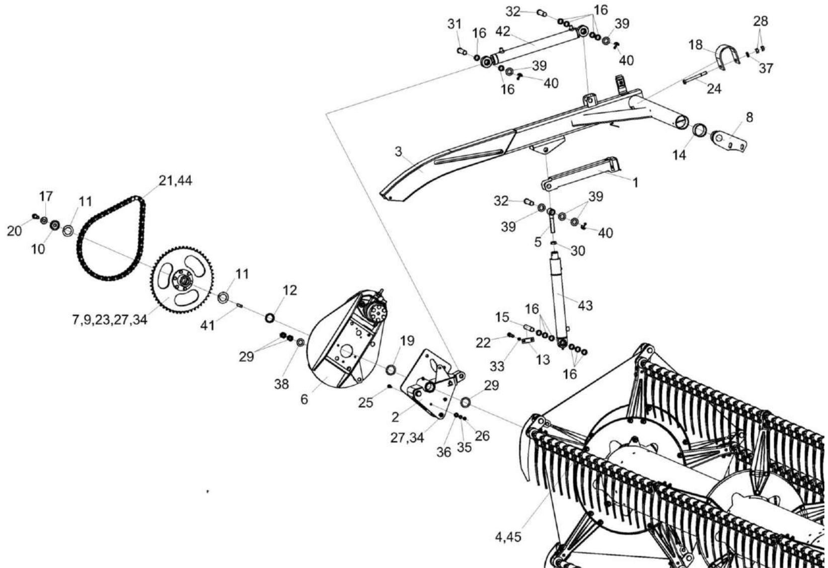
Рисунок 10 – Установка мотвила КЗК-1492-2503000 (лист 2)
