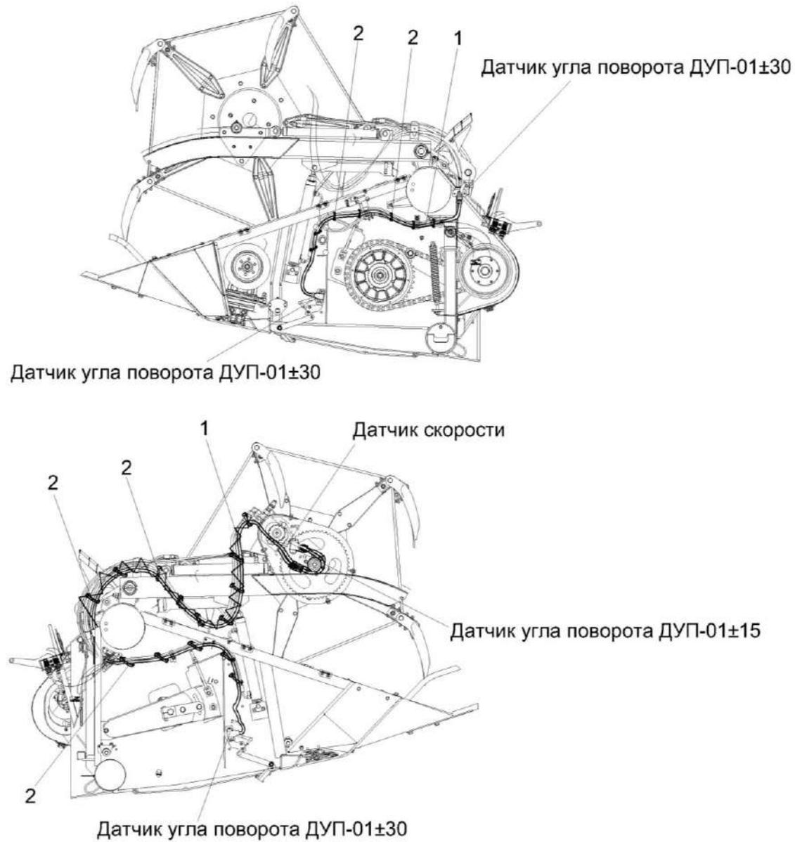
Рисунок 53 – Электрооборудование жатки для сои ЖЗС-9-2 КЗК-1492-0719000
