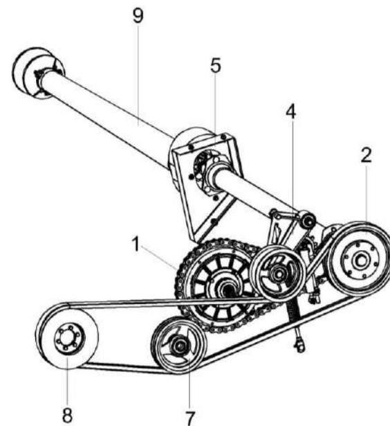
Рисунок 17 – Установка приводов КЗК-1492-2504000 (лист 1)
