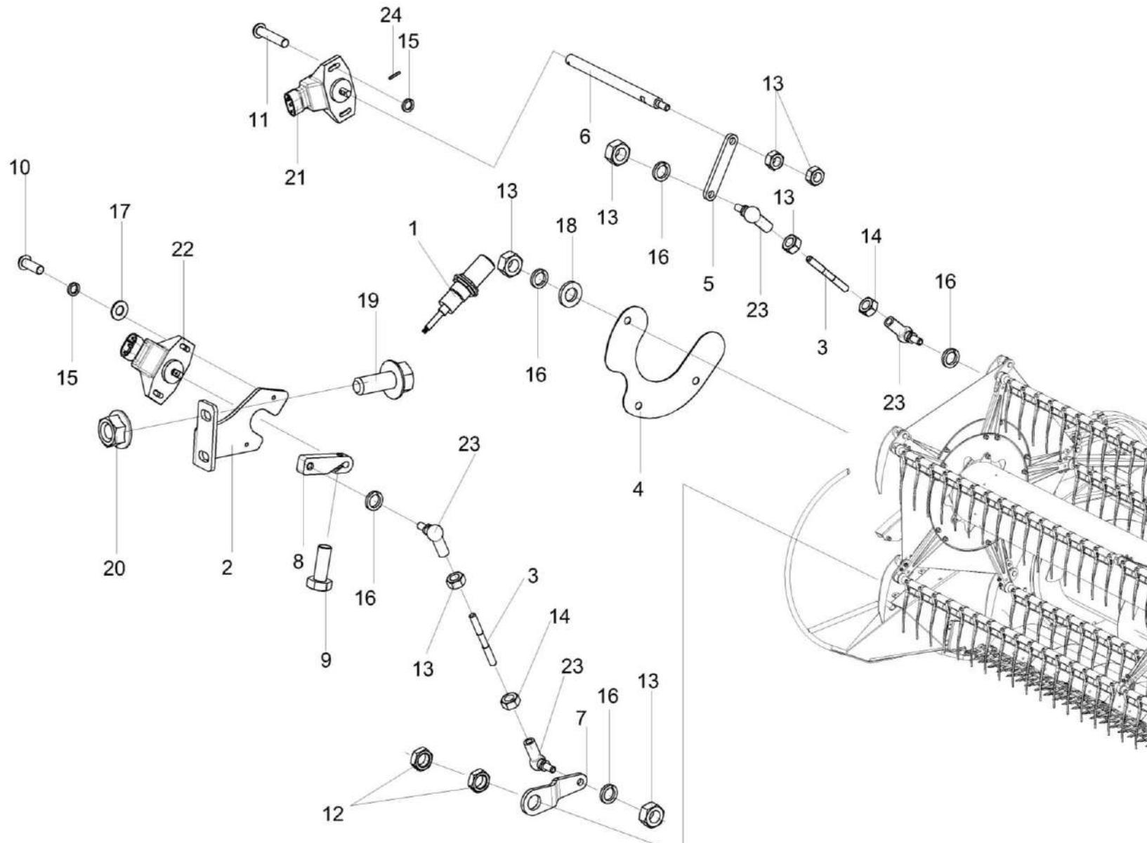
Рисунок 52 – Установка датчиков КЗК-1492-2506000 (лист 2)
