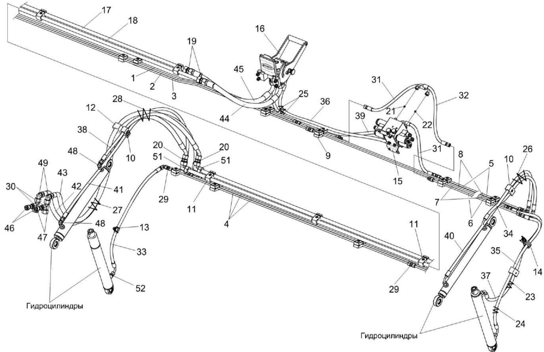
Рисунок 54 – Гидросистема жатки для сои ЖЗС-9-2 КЗК-1492-0687000
