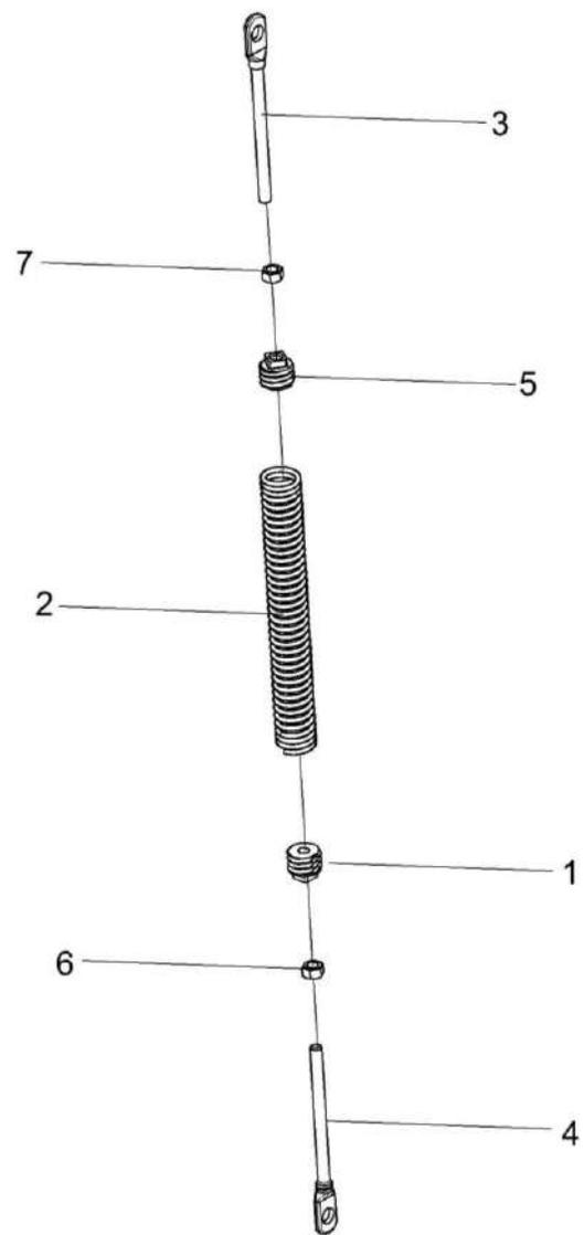
Рисунок 24 – Пружина КЗК 2500020
