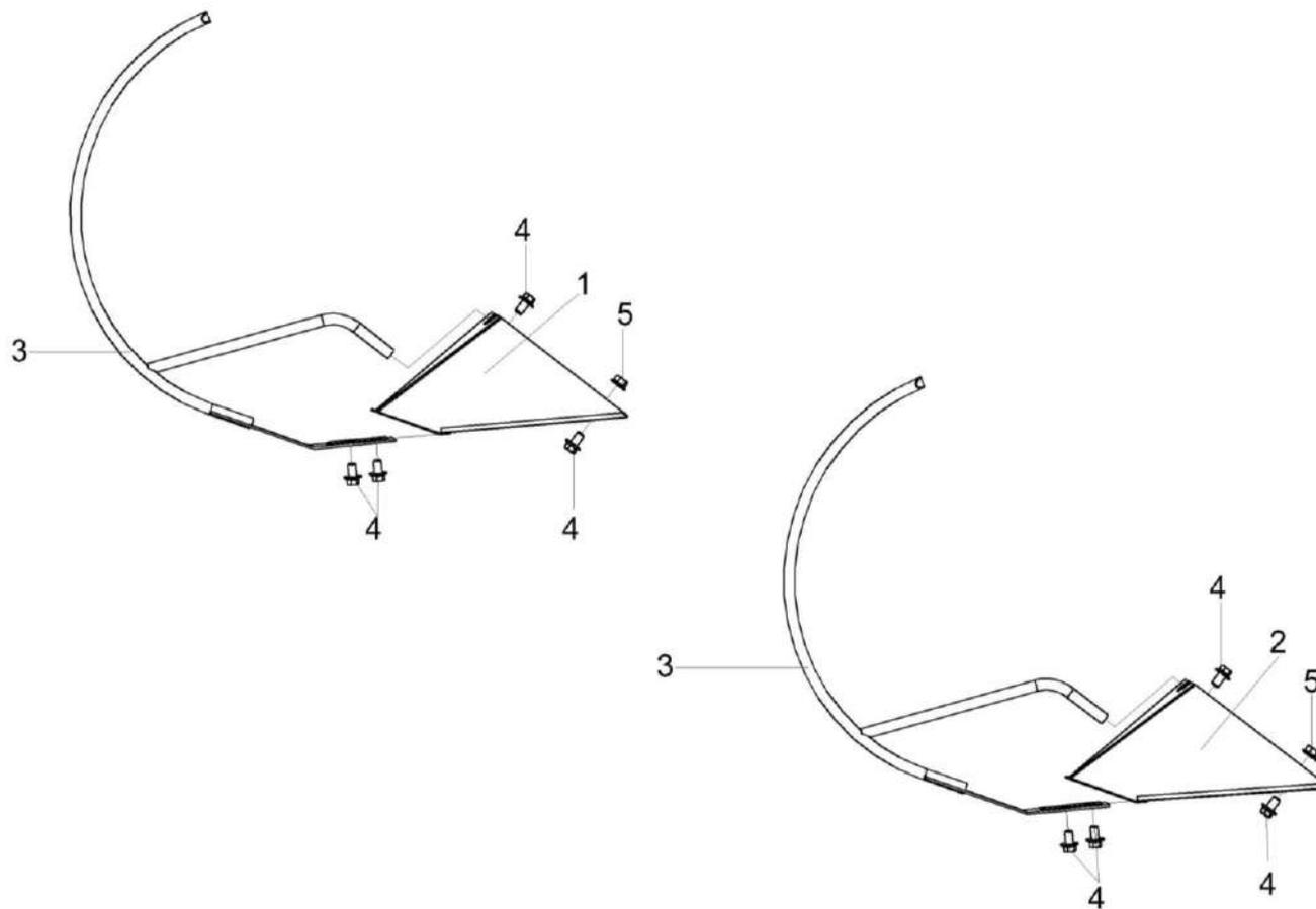
Рисунок 47 – Установка делителей КЗК-1492-2518000
