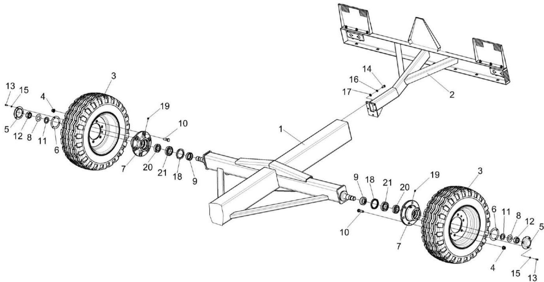
Рисунок 64 – Установка задних колес КЛ 0109500 и балки габаритной КЗК 1592300
