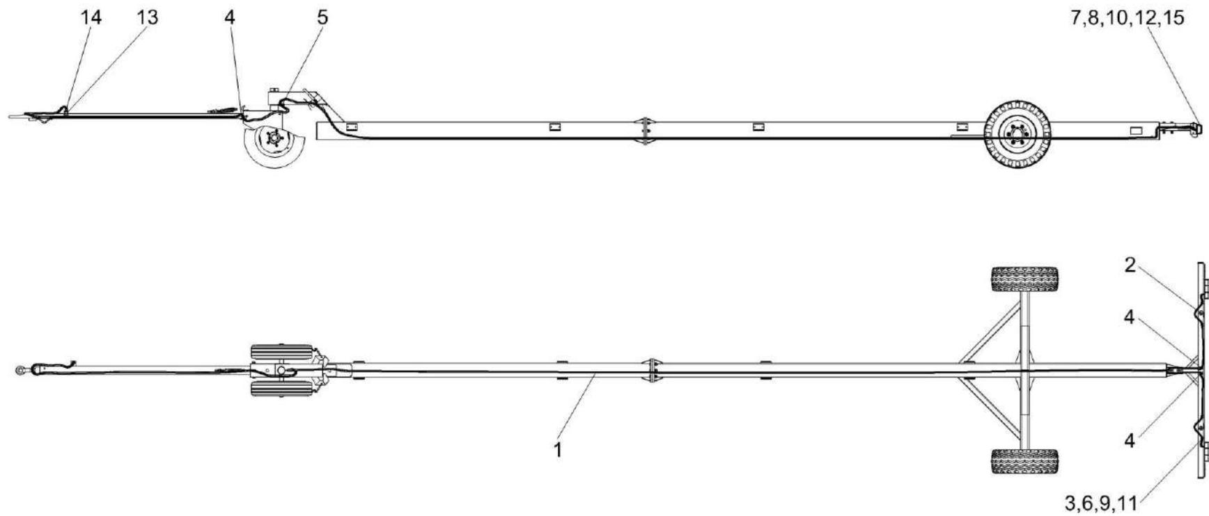
Рисунок 70 – Установка электрооборудования тележки транспортной КЗК 0715900
