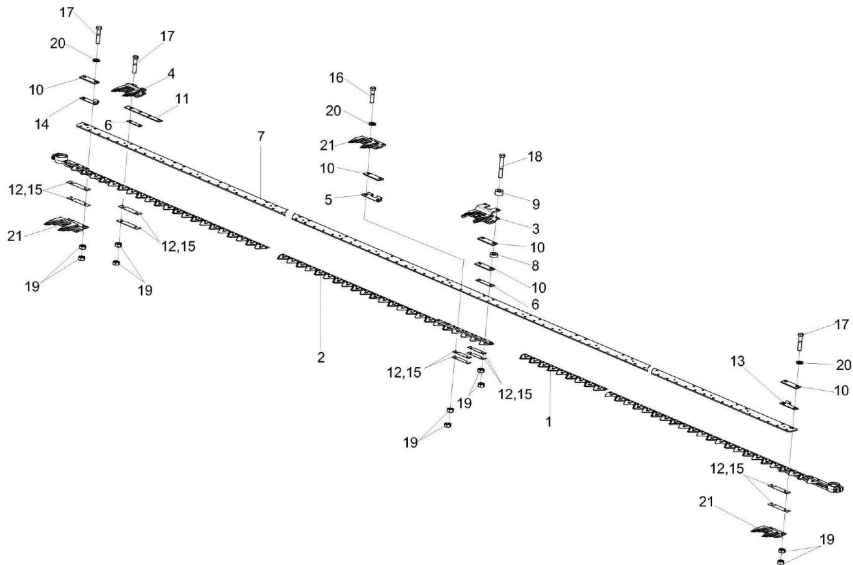
Рисунок 31 – Аппарат режущий КЗК-9-1-2507050
