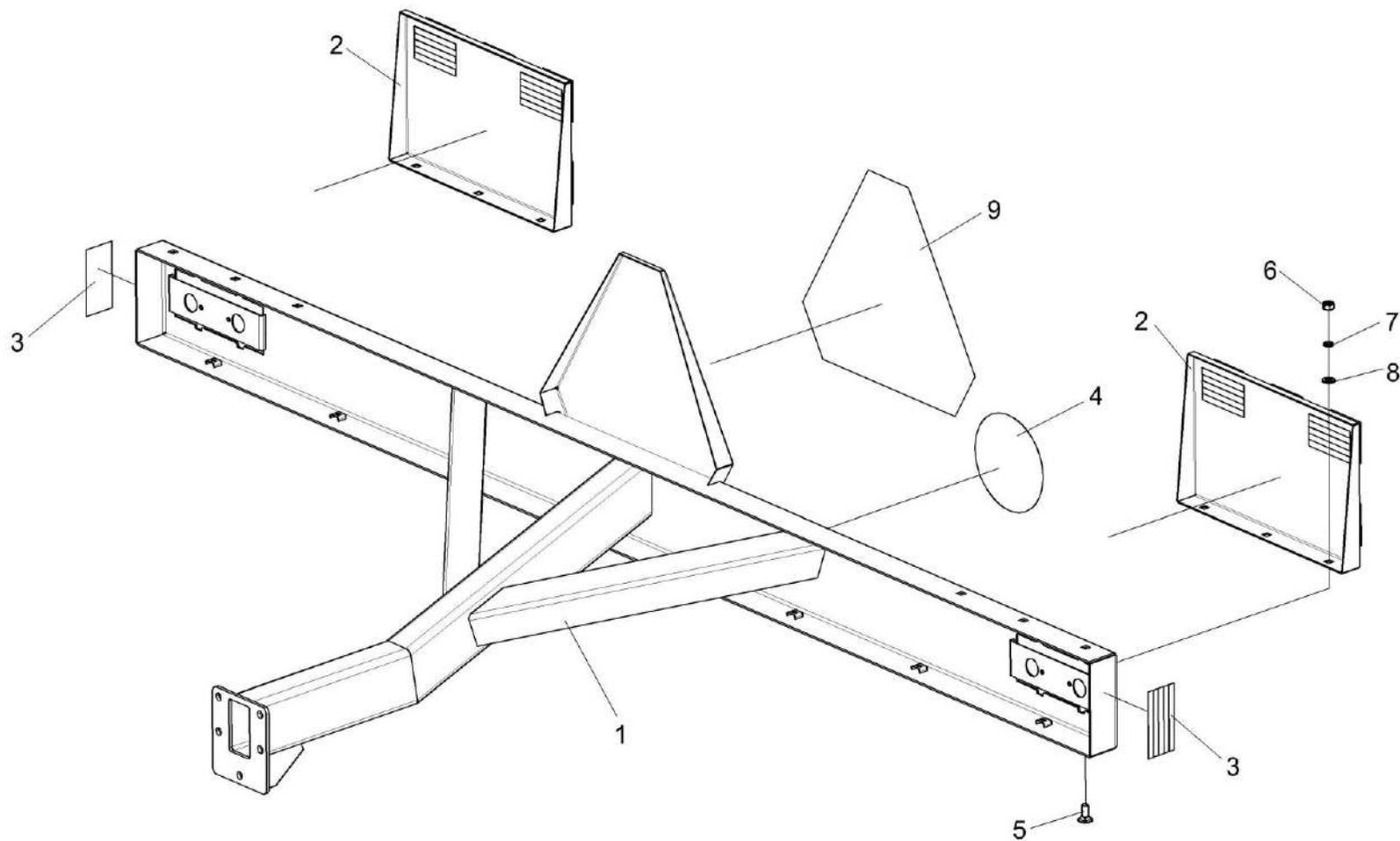
Рисунок 66 – Балка габаритная КЗК 1592300
