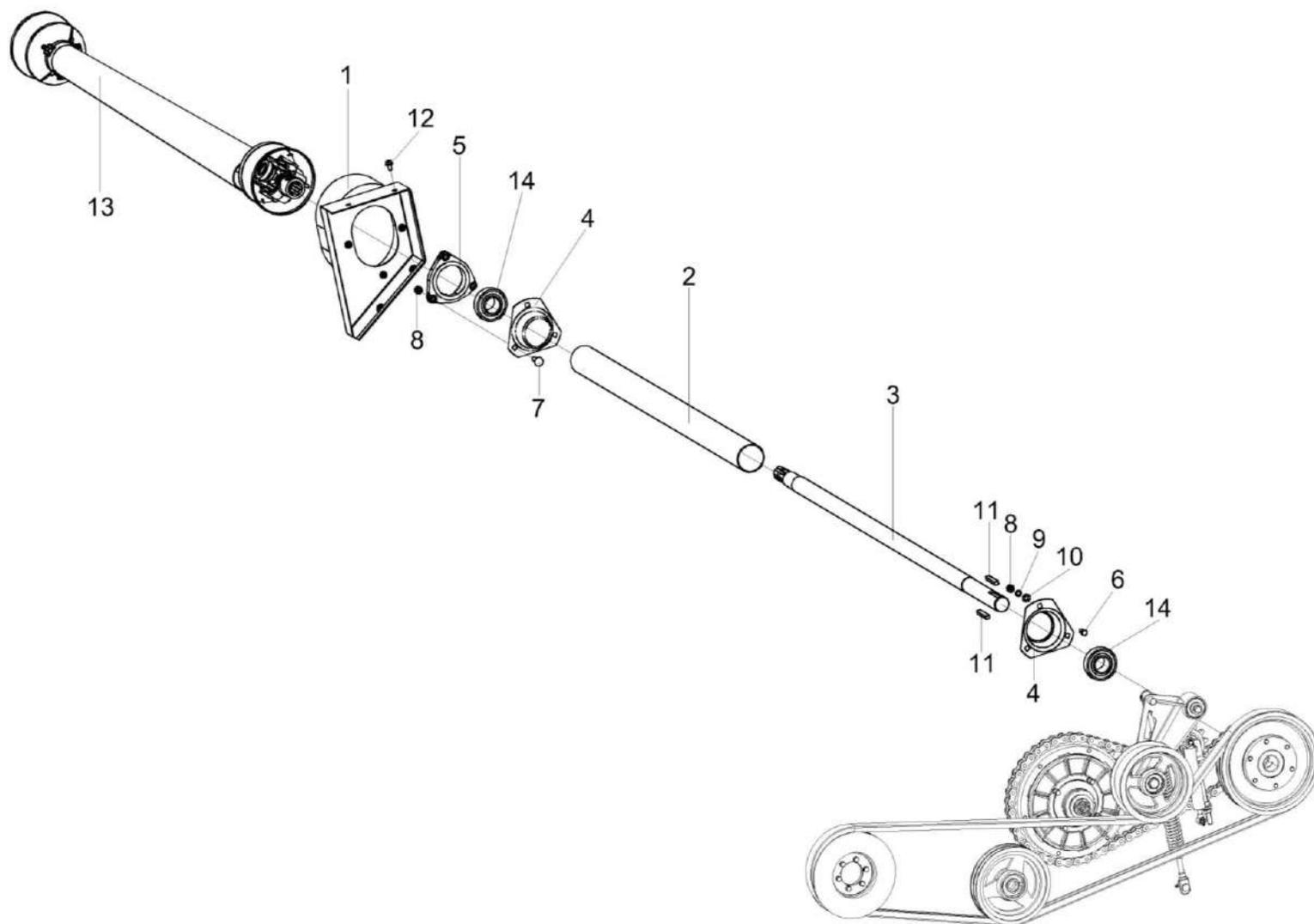
Рисунок 18 – Установка приводов КЗК-1492-2504000 (лист 2)
