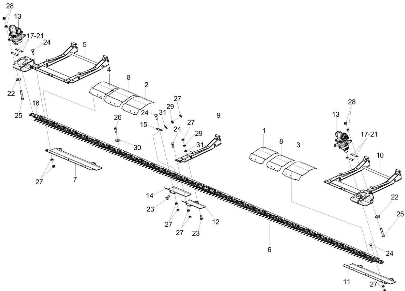
Рисунок 30 – Аппарат режущий КЗК-1492-2507300
