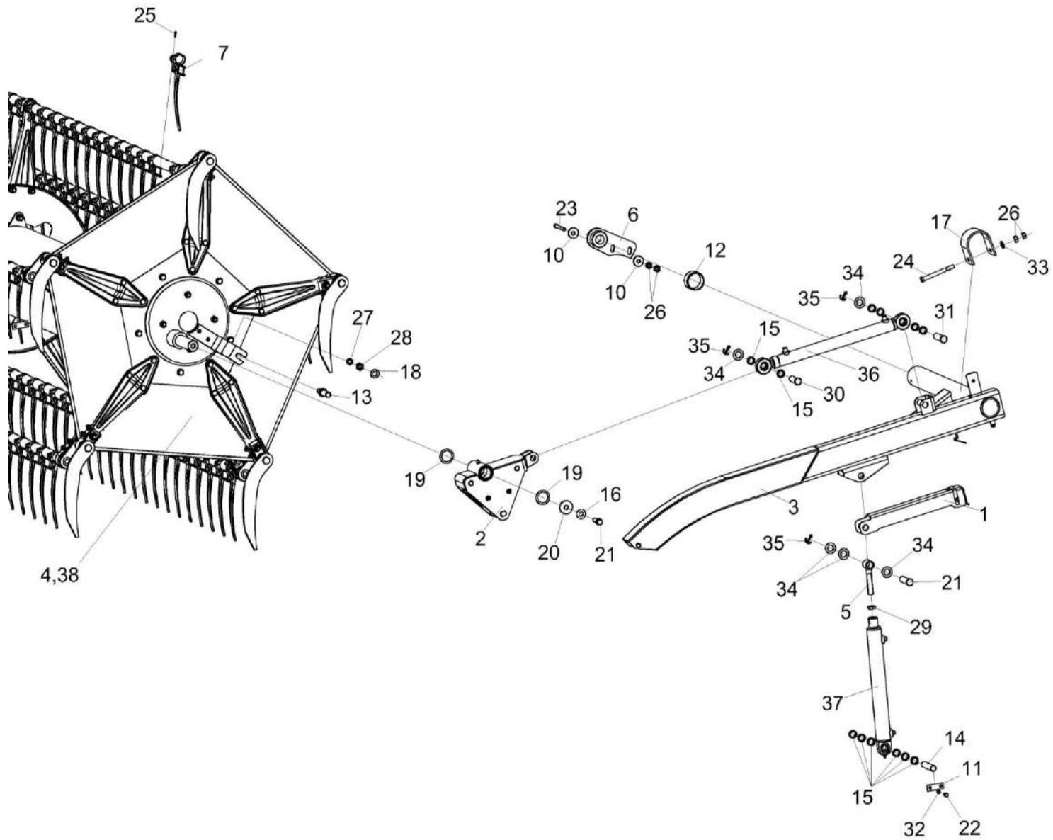
Рисунок 9 – Установка мотовила КЗК-1492-2503000 (лист 1)
