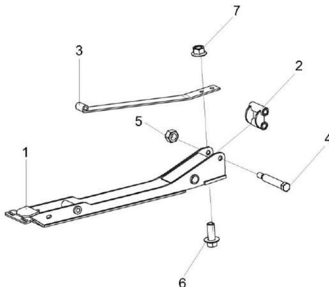
Рисунок 40 – Рычаг КЗК 2503000Б
