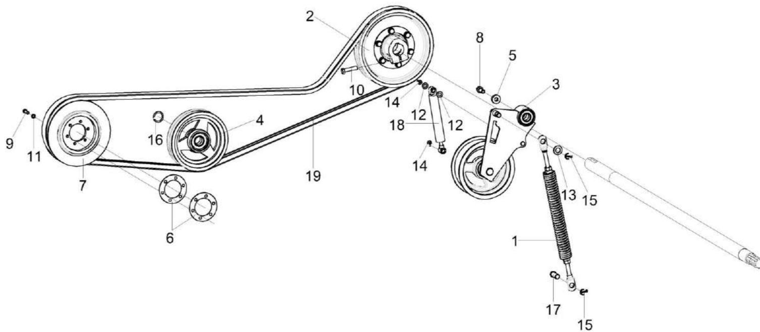
Рисунок 22 – Установка приводов КЗК-1492-2504000 (лист 6)
