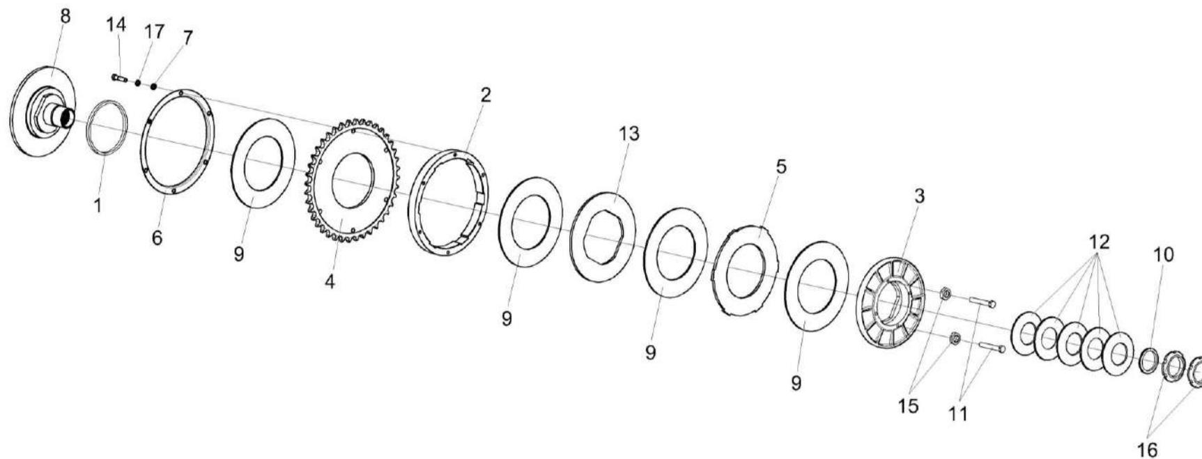
Рисунок 23 – Муфта предохранительная КГС 0202100-04
