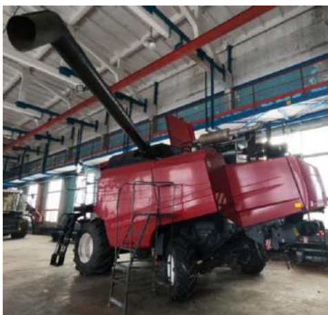
Рисунок 3.12 – Вид на трубу выгрузного шнека, повернутую на угол не менее 50°
