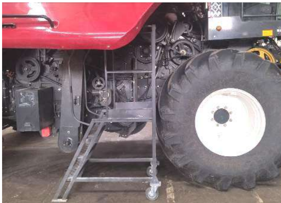
Рисунок 3.3 – Лестница с площадкой для заправки насоса АЦСС
