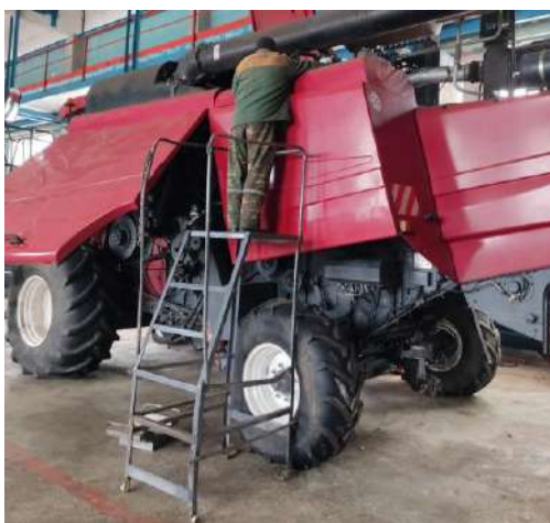
Рисунок 3.13 – Вид на лестничную площадку с оператором при замене напорного фильтроэлемента ГСТ
