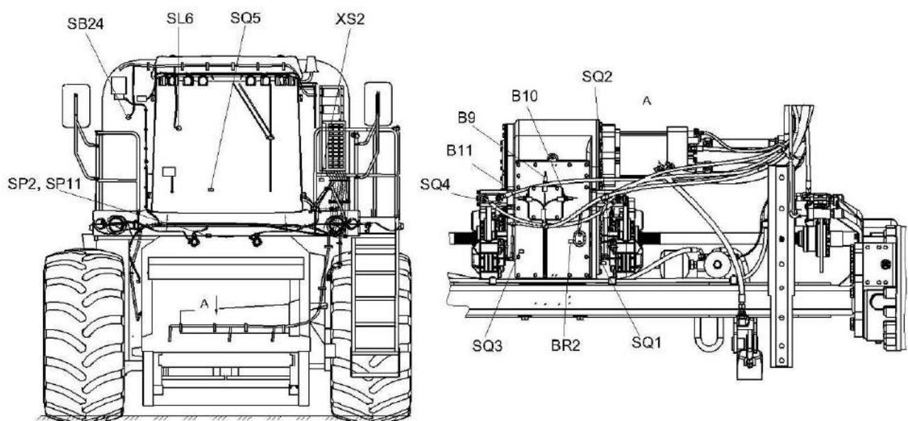
SP2, SP11 - датчик давления в рабочей тормозной системе; SB24 - концевой выключатель блокировки лаза в бункере; SL6 - датчик заполнения бункера 70%; SQ5 - датчик оператора в кресле; XS2 - разъем диагностики двигателя; SQ3, SQ4 - датчик контроля износа правой колодки тормозов; B11 - датчик включения второй передачи; B9 - датчик включения нейтральной передачи; B10 - датчик включения первой передачи; SQ1, SQ2 - датчик контроля износа левой колодки; BR2 - датчик скорости движения
