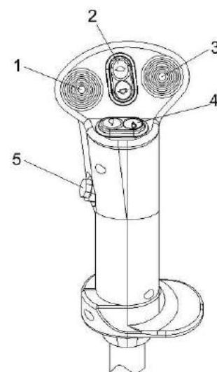
1 – переключатель управления наклонной камерой и системой «Автоконтур»;
