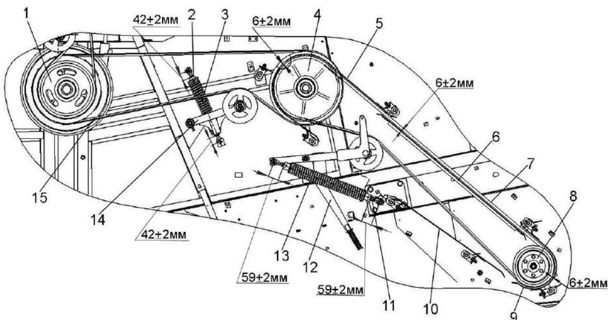
1, 4, 8 – шкивы; 2, 11 – гайки; 3, 13 – пружины; 5, 6, 9, 10 – щитки; 7, 15 – ремень; 12, 14 – рычаги
