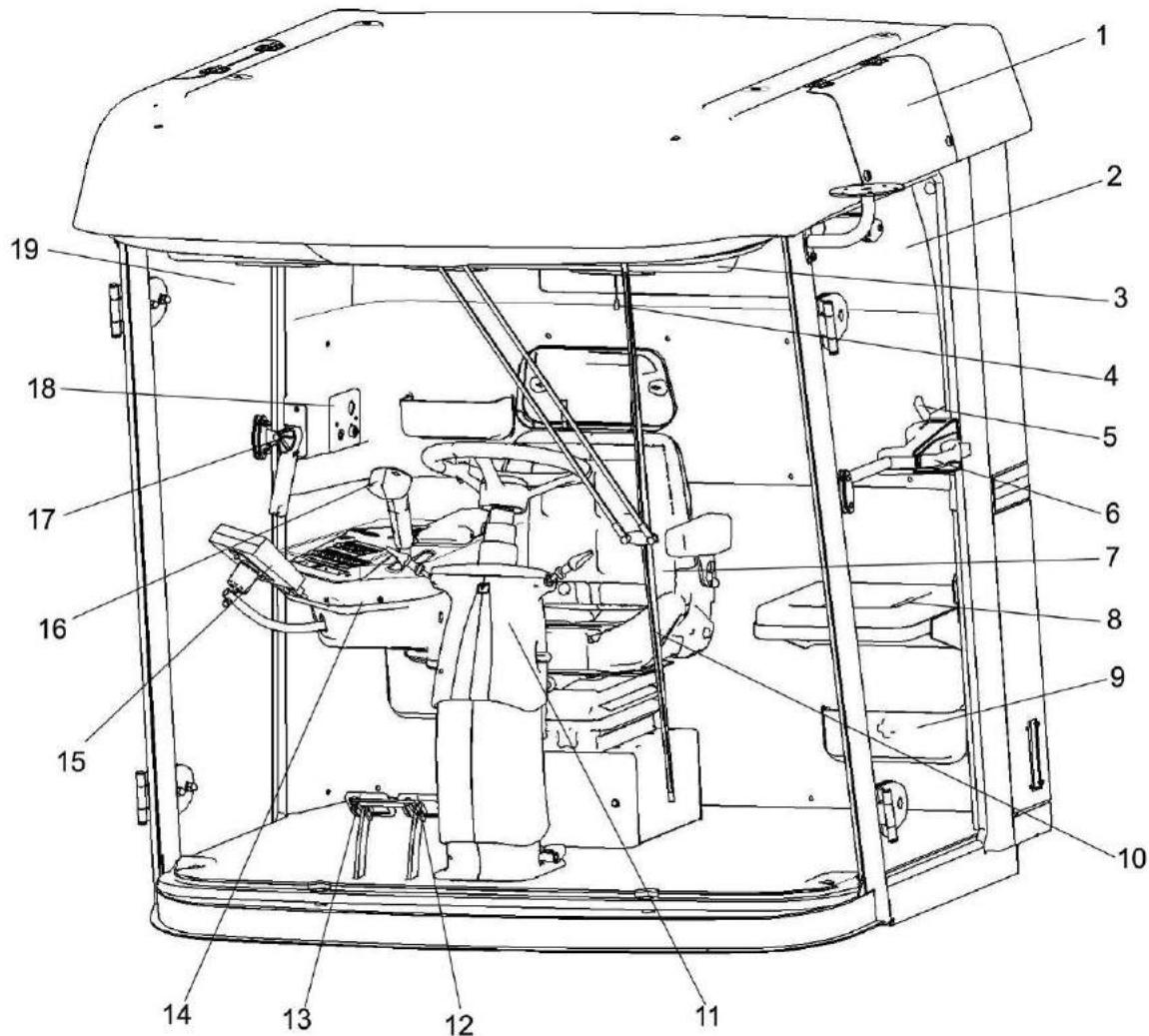
1 – крыша кабины; 2 – дверь; 3 – шторка солнцезащитная; 4 – фиксатор шторки; 5, 6 – ручки замка двери; 7 – сиденье оператора; 8 –сиденье; 9 – место для аптечки; 10 – стеклоочиститель ветрового стекла; 11 – рулевая колонка; 12, 13 – тормозные педали; 14 – пульт управления; 15 – модуль терминальный; 16 – рукоятка управления скоростью движения; 17 – ручка; 18 – панель боковая; 19 – дверь аварийного выхода
