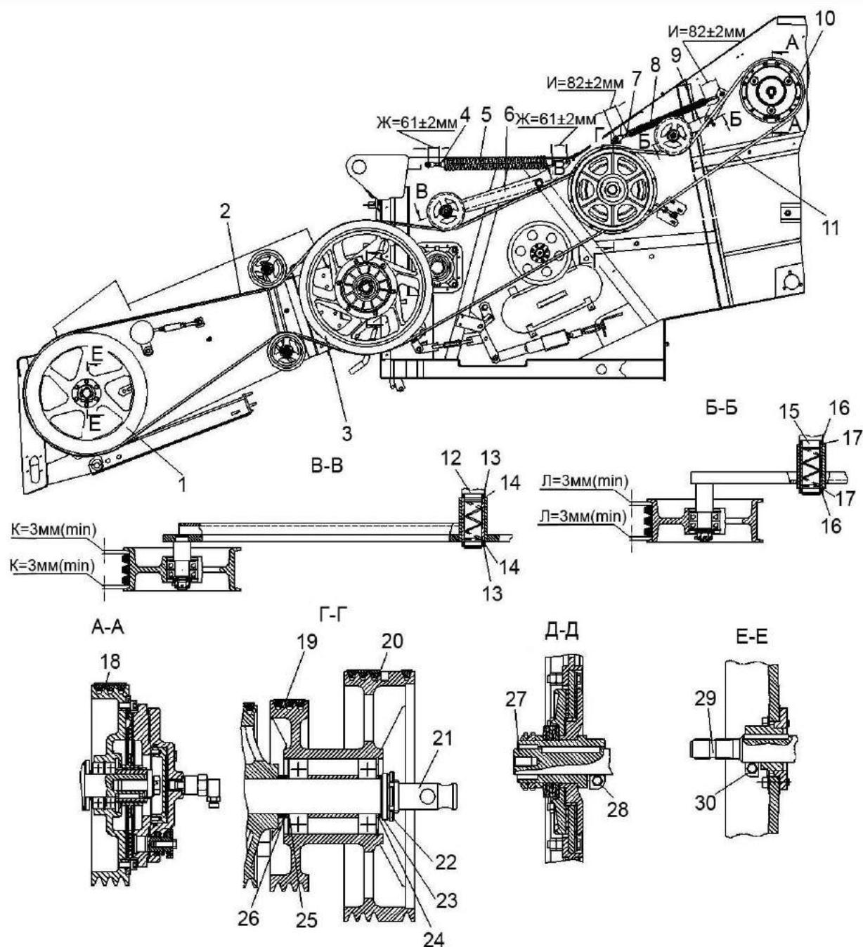
1, 3, 18, 19, 20 – шкивы; 2, 11 – ремни; 4, 7, 22 – гайки; 5, 8 – пружины; 6, 9 – натяжные устройства; 10 - гидромуфта; 12, 15 - оси; 13, 14, 16, 17 - шайбы регулировочные; 21, 27, 29 - валы; 23, 24, 25, 26 - прокладки регулировочные; 28, 30 - болты
