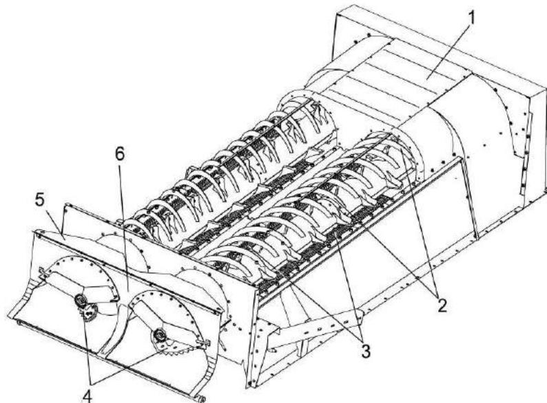
1 – крыша; 2 – кожухи ротора; 3 – деки; 4 – роторы; 5 – проставка; 6 – приемник
