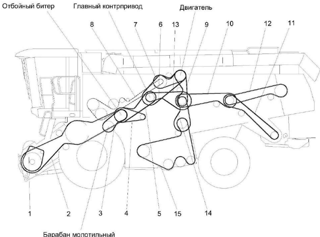
Рисунок К1 – Схема приводов молотилки (вид слева)
