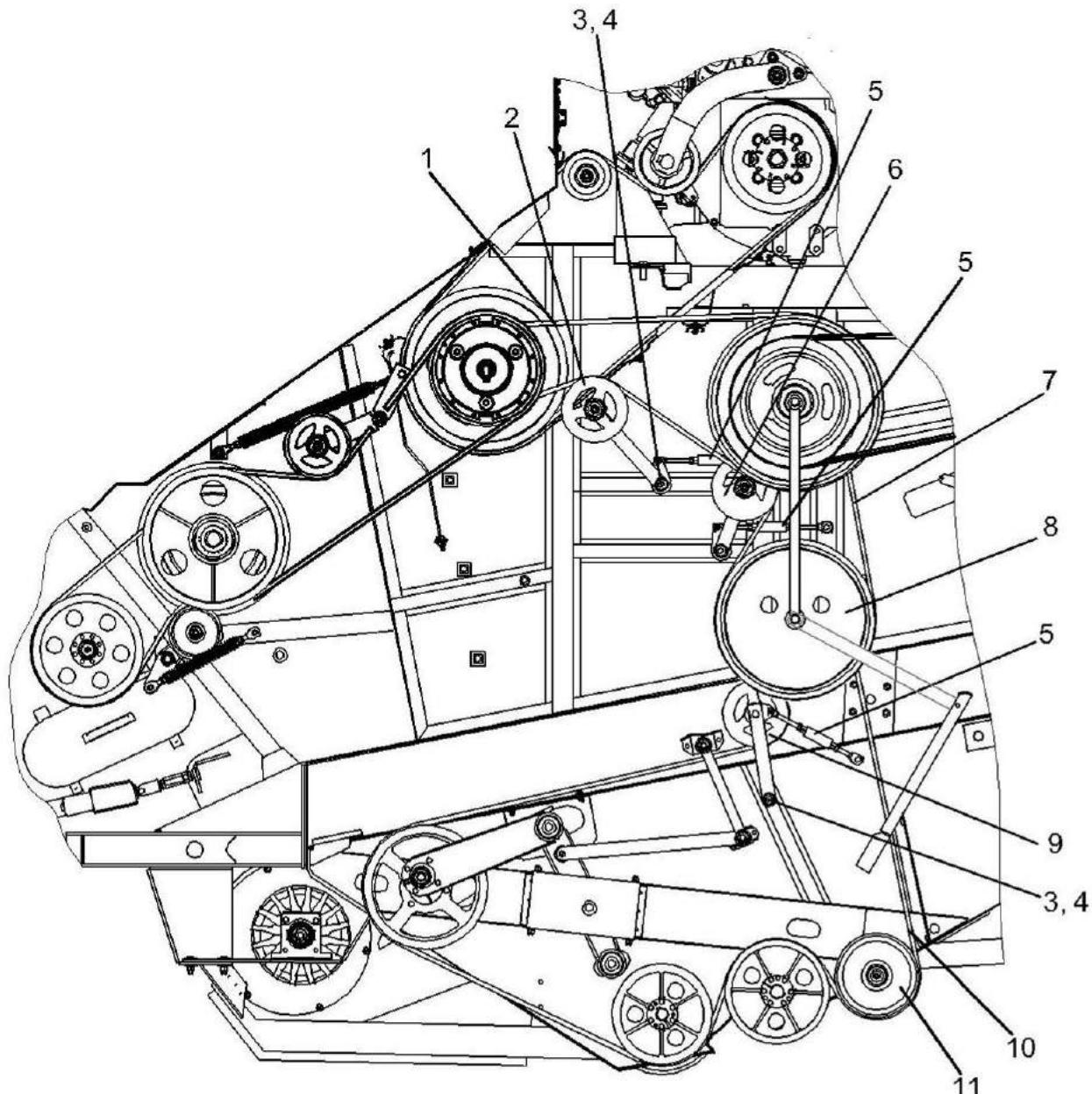
1, 7, 10 – ремни; 2, 6, 9 – рычаги; 3, 4 – гайки; 5 – стяжка; 8 - шкив; 11 – шкив обводной
