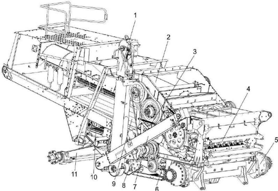
1 – зерновой элеватор; 2 - роторный соломосепаратор; 3 - стрясная доска; 4 - молотильный аппарат; 5 – мост ведущих колес; 6 – вентилятор; 7 – колосовой элеватор; 8 – зерновой шнек; 9 – колосовой шнек; 10 – решетный стан; 11 – управляемый мост
