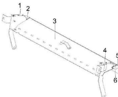
1, 7 – щетки; 2, 6 - уголки; 3 – уплотнитель; 4 - лоток; 5 – планка
