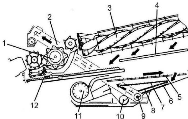
1 – молотильный аппарат; 2 – элеватор колосовой; 3 – роторный соломосепаратор; 4 – скатная доска; 5 – верхнее решето; 6 - поддон колосовой; 7 – нижнее решето; 8 – поддон зерновой; 9 – шнек колосовой; 10 - шнек зерновой; 11 – вентилятор; 12 – стрясная доска
