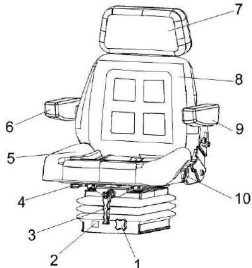
1 – маховик регулировки сиденья по высоте; 2 - индикатор; 3 – рукоятка регулировки системы подпрессоривания сиденья по массе оператора; 4 – рычаг фиксации продольного перемещения сиденья; 5 – подушка; 6 ,9 – подлокотники; 7 – подголовник; 8 – спинка; 10 – рычаг фиксации наклона спинки
