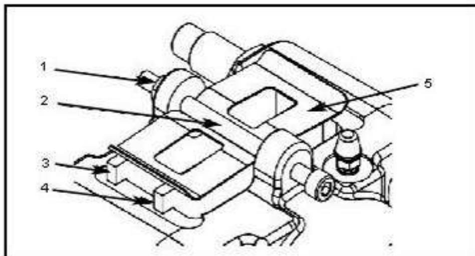
7. Ослабьте контргайку 1 и выкрутите регулировочный винт 2 из корпуса
