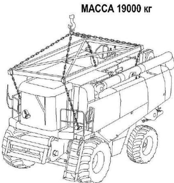
Рисунок 6.1 – Схема строповки молотилки самоходной
