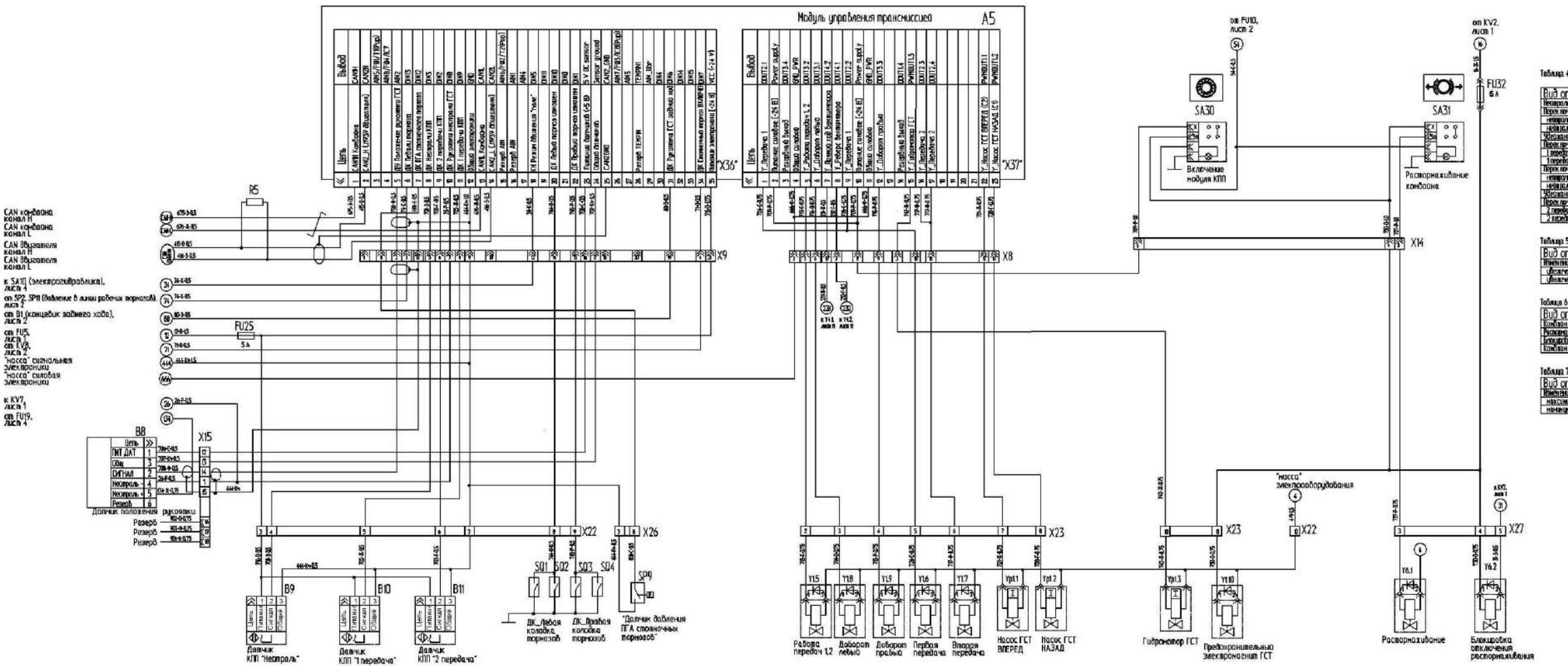
Рисунок Б.7 – Схема электрическая принципиальная комбайна (лист 7)
