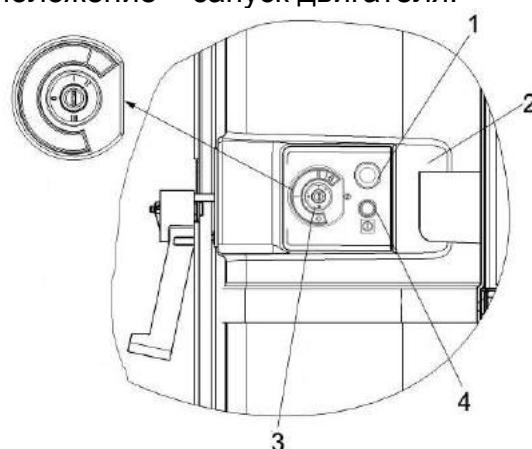
1 – розетка бортовой сети; 2 – стойка кабины; 3 – выключатель стартера и приборов; 4 – выключатель кнопочный включения ПИТАНИЯ
