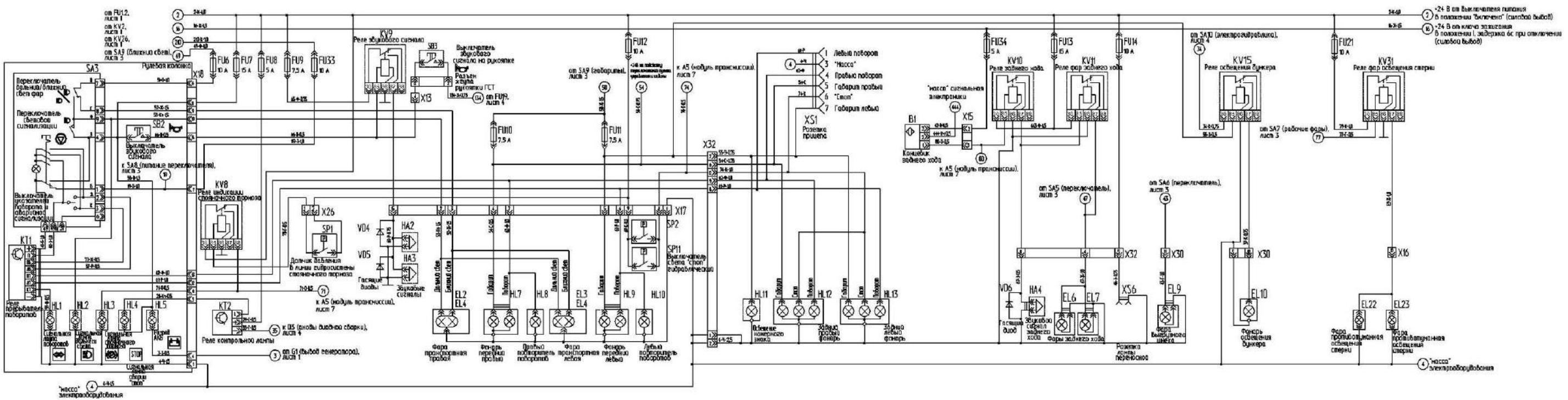
Рисунок Б.2 – Схема электрическая принципиальная комбайна (лист 2)
