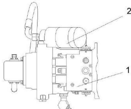
1 – гидронасос; 2 – фильтроэлемент
