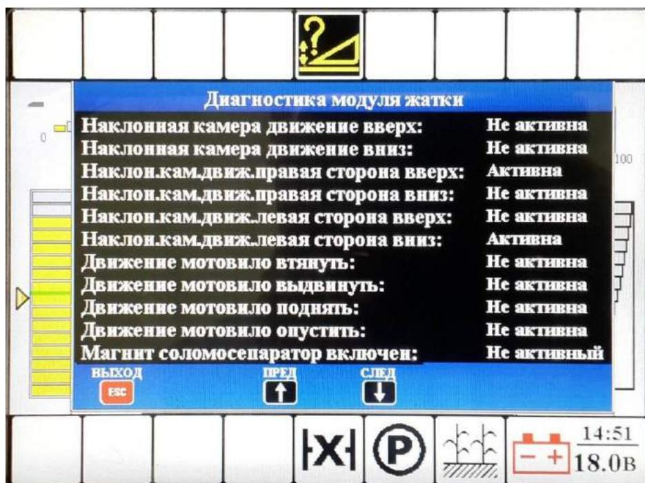
Рисунок Ж. 28— Вид окна «Диагностика модуля жатки»
