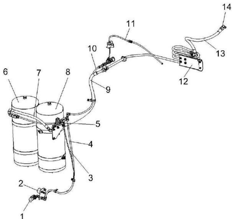
1 – пневмовывод; 2 - манометр; 3, 4, 7 – пневмотрубки; 5 - регулятор давления; 6, 8 – ресиверы; 9, 10, 13 - рукав высокого давления; 11 - рукав низкого давления; 12 – кронштейн; 13 – трубопровод; 14 – штуцер пневмокомпрессора
