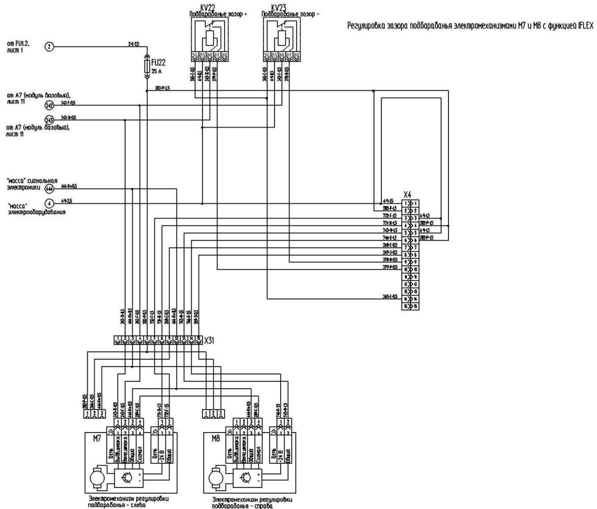
Рисунок Б.13 – Схема электрическая принципиальная комбайна (лист 13)
