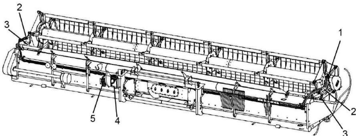
1 – гидромотор привода мотовила; 2 - гидроцилиндры Ц89.1 и Ц89.2 горизонтального перемещения мотовила; 3 - гидроцилиндры Ц89.3 и Ц89.4 подъема мотовила; 4 - гидроблок жатки; 5 - разъем многофункциональный
