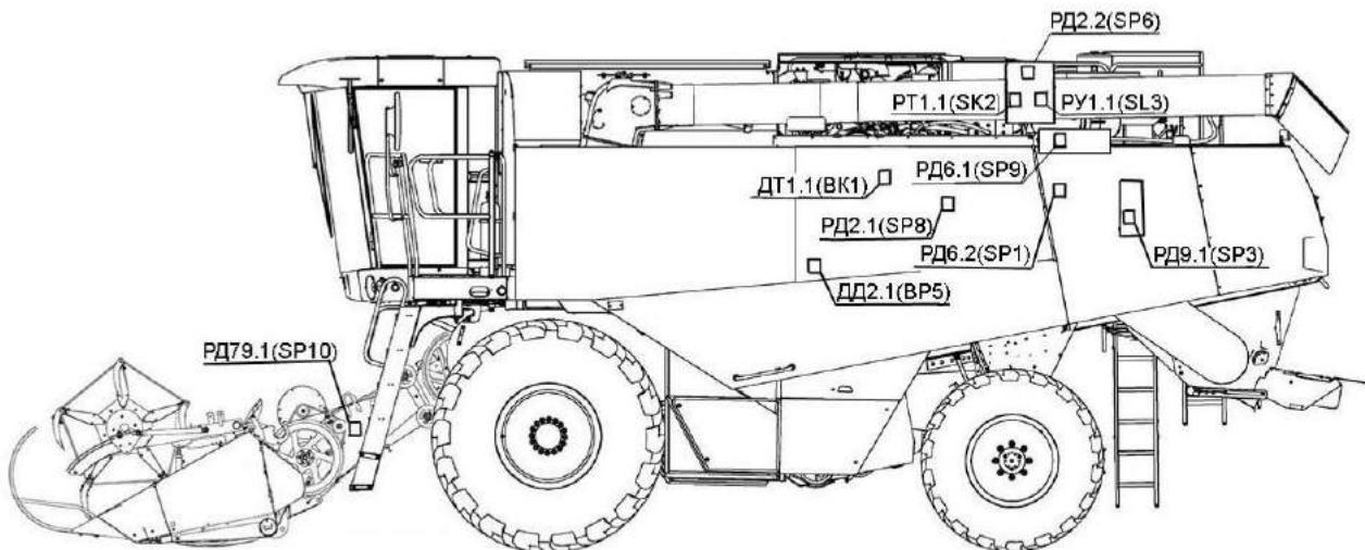
РД - реле давления; РУ - реле уровня; ДД - датчик давления; РТ - реле температуры; ДТ - датчик температуры
