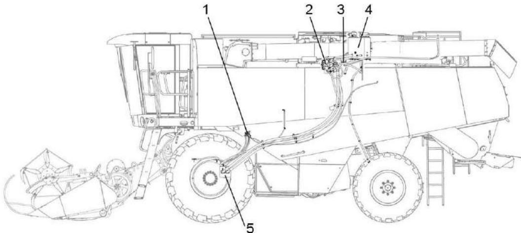
1 – гидроблок управления переключением передач; 2 – гидронасос двухсекционный; 3 – гидроблок поворота вала мотора ГСТ; 4 – бак масляный; 5 - гидромотор
