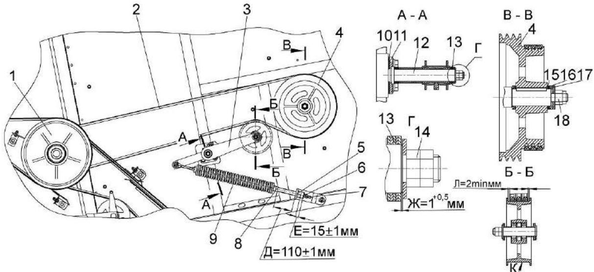
1, 4 – шкивы; 2 - ремень; 3 – рычаг; 4 – гайки; 5 – винт; 6, 7, 14, 18 - гайки; 8 - контргайка; 9 - пружина; 10, 11 – набор прокладок; 12 – опора; 13, 15, 16, 17 – шайбы
