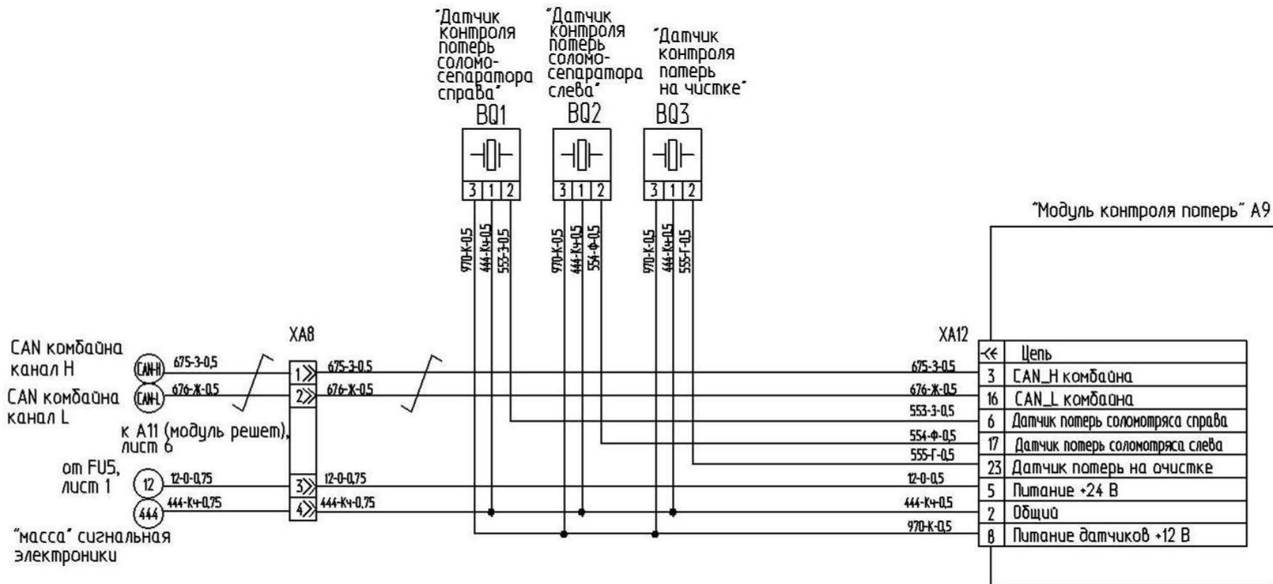
Рисунок Б.10 – Схема электрическая принципиальная комбайна (лист 10)
