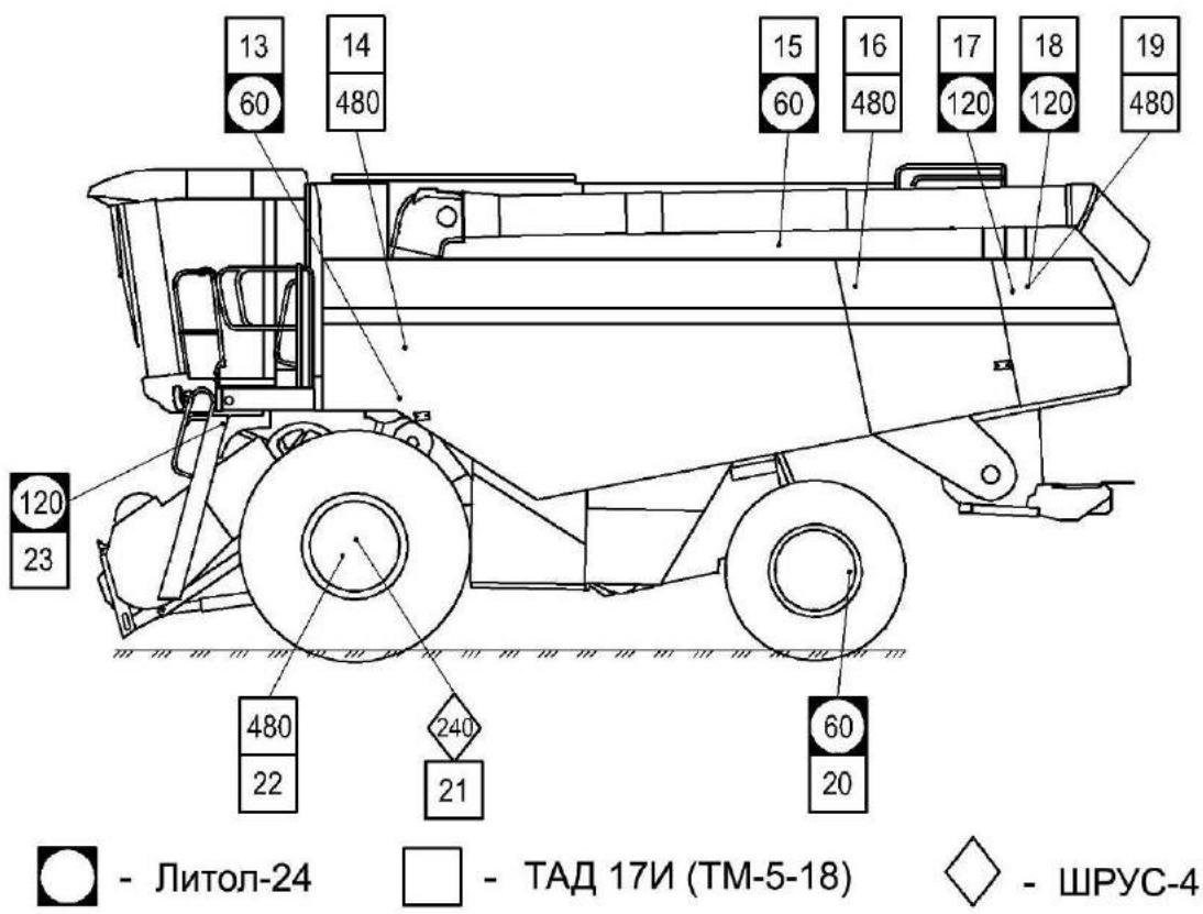
Рисунок 3.2 – Смазка молотилки самоходной (вид слева)
