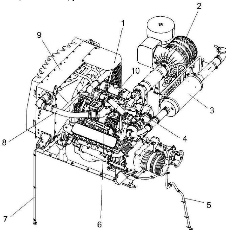
1 – ограждение; 2 – воздухоочиститель; 3 – глушитель; 4 – установка топливной системы;
