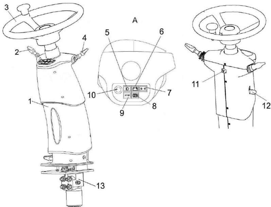
1 – корпус; 2 – переключатель указателей поворотов и света; 3 – рулевое колесо; 4 – зажим; 5 – переключатель стеклоочистителей; 6 – контрольная лампа дальнего света; 7 – контрольная лампа зарядки АКБ; 8 – контрольная лампа указателей поворотов; 9 – контрольная лампа стояночного тормоза; 10 – контрольная лампа сигнализации аварийных режимов «СТОП»; 11 – выключатель звукового сигнала; 11- выключатель аварийной сигнализации; 12 - рукоятка; 13 – насос-дозатор
