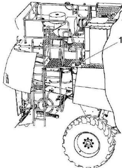
1 – крышка заливной горловины топливного бака
