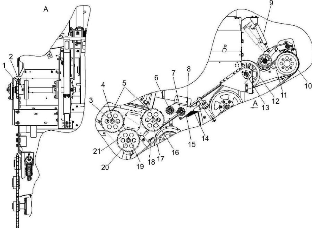
1, 5, 6, 7, 21 – звездочки; 2 – муфта; 3, 13, 17, 20 – валы; 4, 16, 19 – винт стопорный; 8 – механизм натяжения; 9 – гидроцилиндр зернового бункера; 10, 12 – шкивы; 11 – ремень; 14 – пружина; 15 – гайка; 18 - цепь
