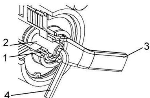
1 – контргайка; 2 – регулировочный болт;
