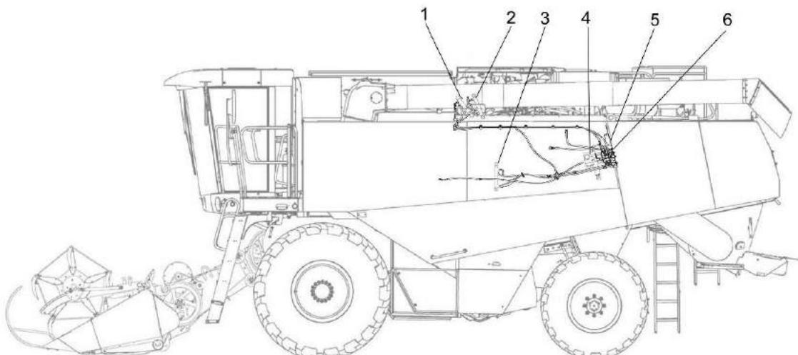
1 - гидроцилиндр главного привода; 2 - гидроцилиндр соломоизмельчителя; 3 - гидроцилиндр выгрузки зернового бункера; 4 – предохранительный клапан низкого давления; 5 – гидроблок низкого давления; 6 - клапан обратный
