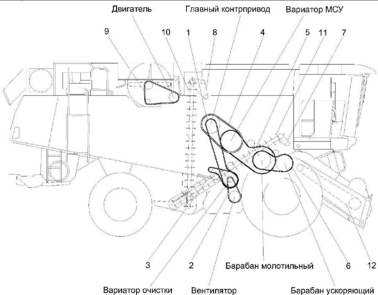
Рисунок К2 – Схема приводов молотилки (вид справа)
