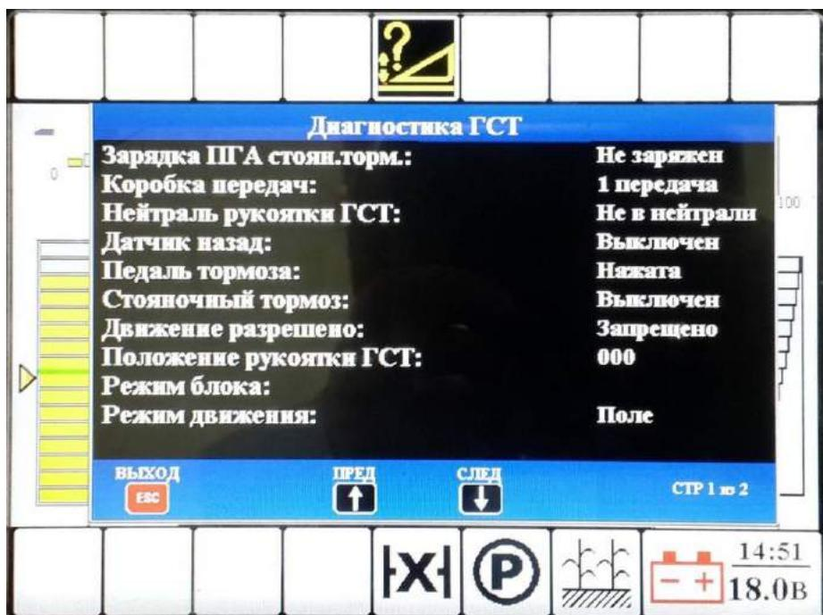
Рисунок Ж. 26— Вид окна «Диагностика модуля ГСТ»
