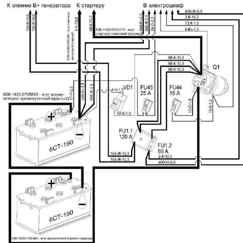
FU 1.1 (120A) – предохранитель защиты от переполюсовки (перегорает при неправильном подсоединении аккумуляторных батарей, при механическом повреждении жгута установки двигателя или жгута питания на участке ящик АКБ-Генератор);
