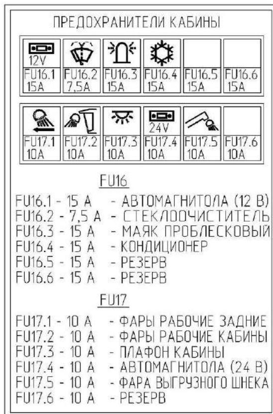
Рисунок 1.41 – Схема расположения предохранителей
