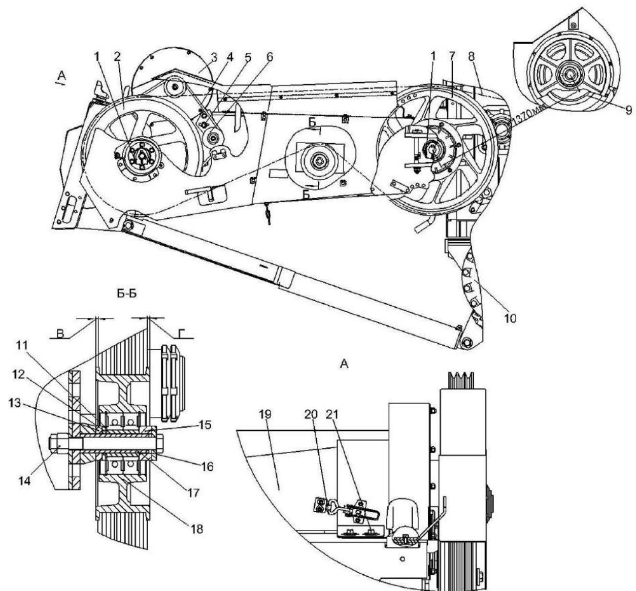
1, 5, 21 – болты; 2, 7, 9 – шкивы; 3 – вентилятор; 4 – ремень; 6 – ролик натяжной; 8 - аппарат молотильный; 10 - мост ведущих колес; 11, 12, 13, 15, 16 - шайбы; 14 - гайка; 17 - втулка; 18 - ролик; 19 - воздухозаборник; 20 - тяга
