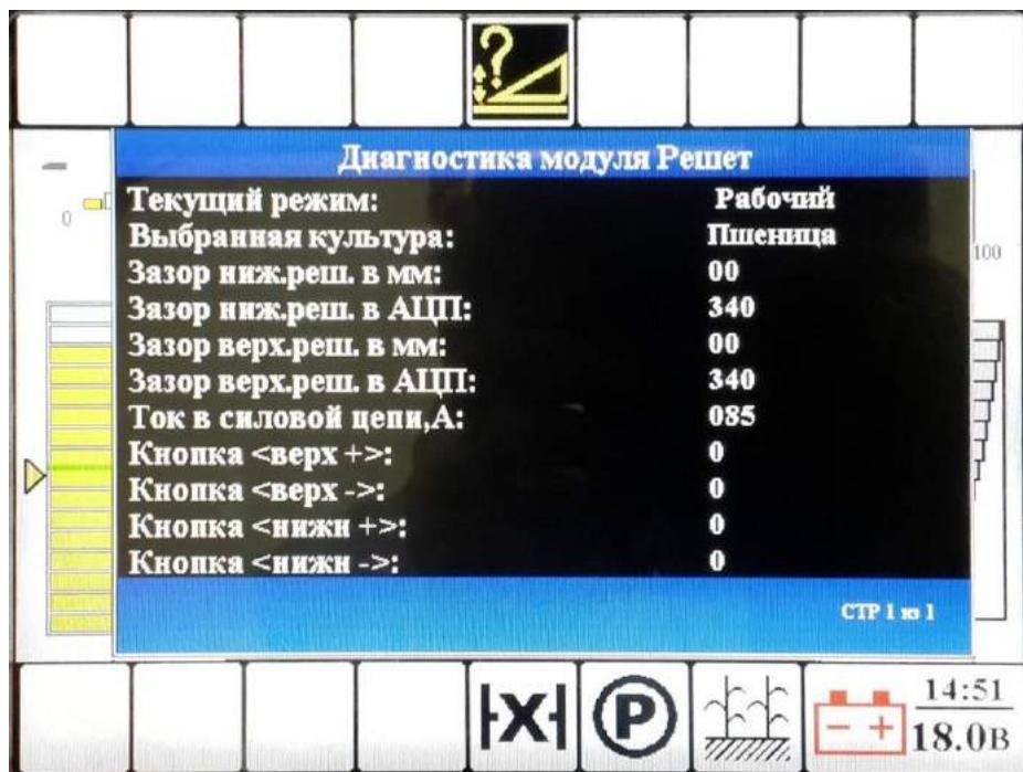
Рисунок Ж. 27— Вид окна «Диагностика модуля решет»
