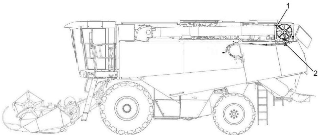
1 - радиатор масляный; 2 – гидроблок вентилятора
