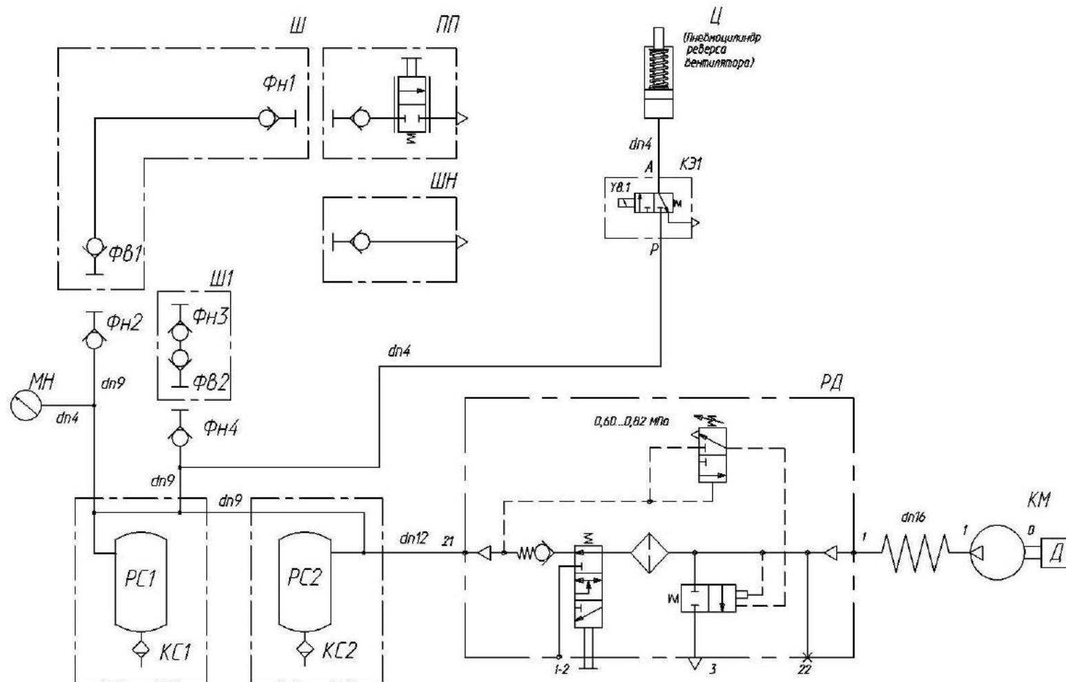
КМ - компрессор; КЭ1 - клапан электромагнитный; РС1, РС2 – ресиверы; ШН – шланг для накачивания шин; КС1, КС2 – краны слива конденсата; МН – манометр; Фн1, Фн2, Фн3, Фн4, Фв1, Фв2 – фитинг; Ш, Ш1 – шланг; ПП – пневмопистолет обдувочный; РД – регулятор давления
