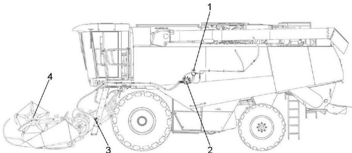
1 – клапан промывочный; 2 – гидронасос; 3 – разъем многофункциональный электрогидросистем; 4 -гидромотор М89.1 привода мотовила (на правой стороне)
