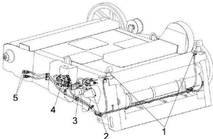
1 – гидроцилиндры Ц79.1 и Ц79.2; поперечного копирования; 2 – гидроцилиндр Ц79.3 включения реверса; 3 - гидромотор реверса; 4 – гидроблок поперечного копирования и реверса; 5 - муфты быстрого соединения
