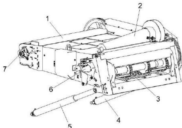
1 – рама; 2 – вентилятор; 3 – цепочно–планчатор; 4, 5 - гидроцилиндры подъема наклонной камеры; 6 – механизм реверса; 7 – вал верхний; 8- вал; 9 – упор; 10 – цепочка
