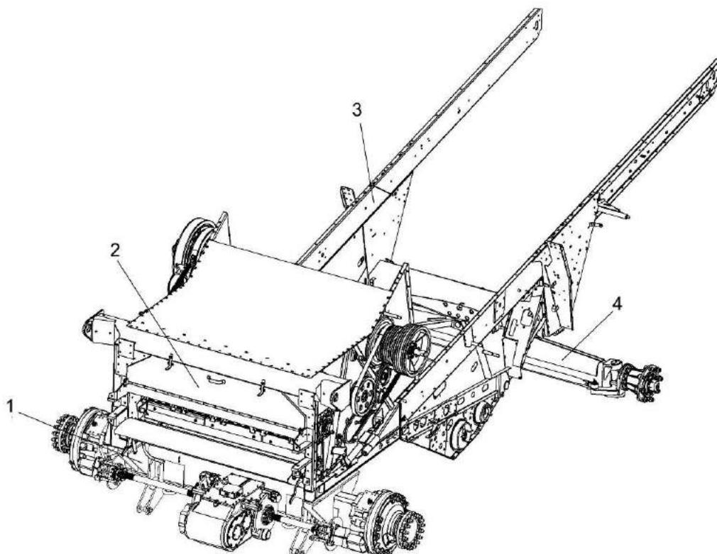
1 – мост ведущих колес; 2 – аппарат молотильный; 3 – рама; 4 – мост управляемых колес
