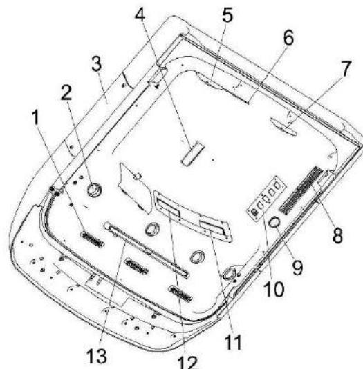
1, 2 – дефлекторы; 3 – место установки воздушного фильтра; 4 – плафон освещения кабины; 5, 7 – динамики автомагнитолы; 6 – панель блока предохранителей; 8 – решетка фильтра рециркуляции воздуха; 9 – плафон индивидуального освещения; 10 – панель выключателей; 11 – панель управления кондиционером; 12 – автомагнитола; 13 – шторка солнцезащитная
