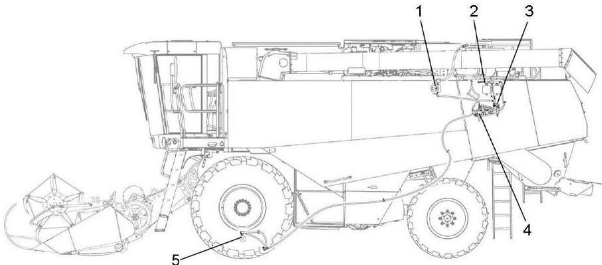
1 – гидронасос двухсекционный (вторая секция); 2 – блок пневмогидроаккумулятора; 3 – клапан зарядки пневмогидроаккумулятора (ПГА); 4 – блок клапанов электроуправляемых; 5 - гидроцилиндры Ц6.1 и Ц6.2 стояночного тормоза
