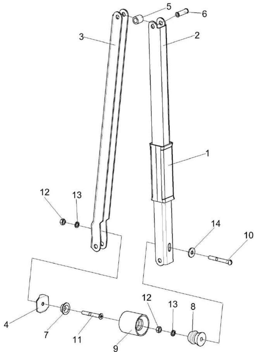
Рисунок 166 – Механизм фиксации капота КЗР 0200370В
