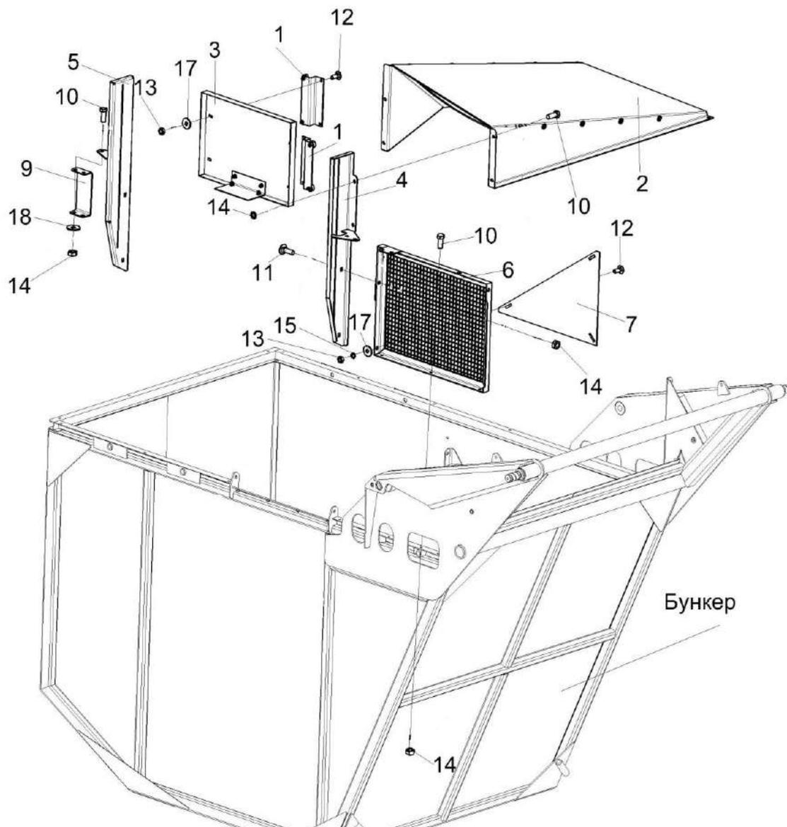
Рисунок 79 – Установка бункера КП-4-0105000Б (лист 6)
