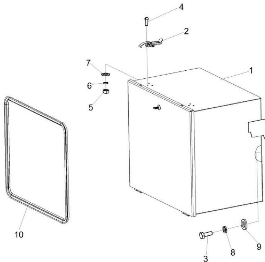
Рисунок 14 – Установка ящика инструментального КП-4-0131000
