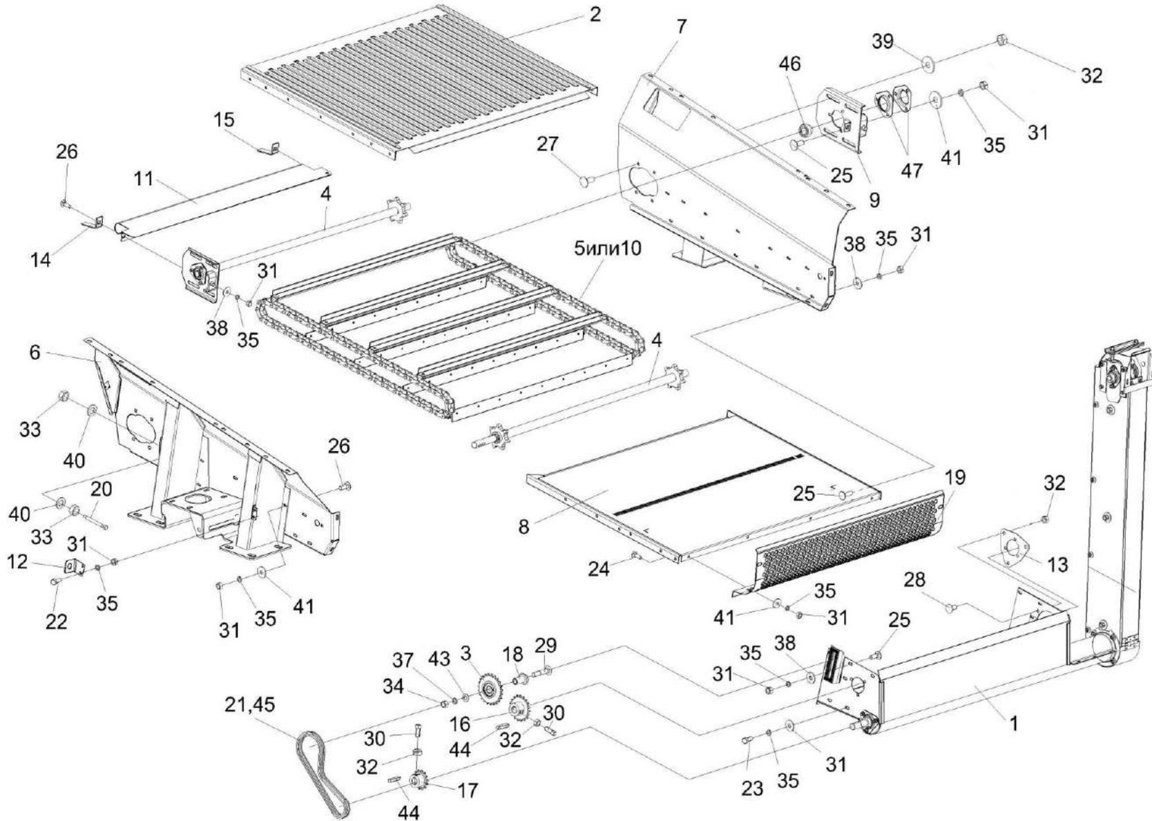
Рисунок 23 – Транспортер обертки КП-4-0102290Б
