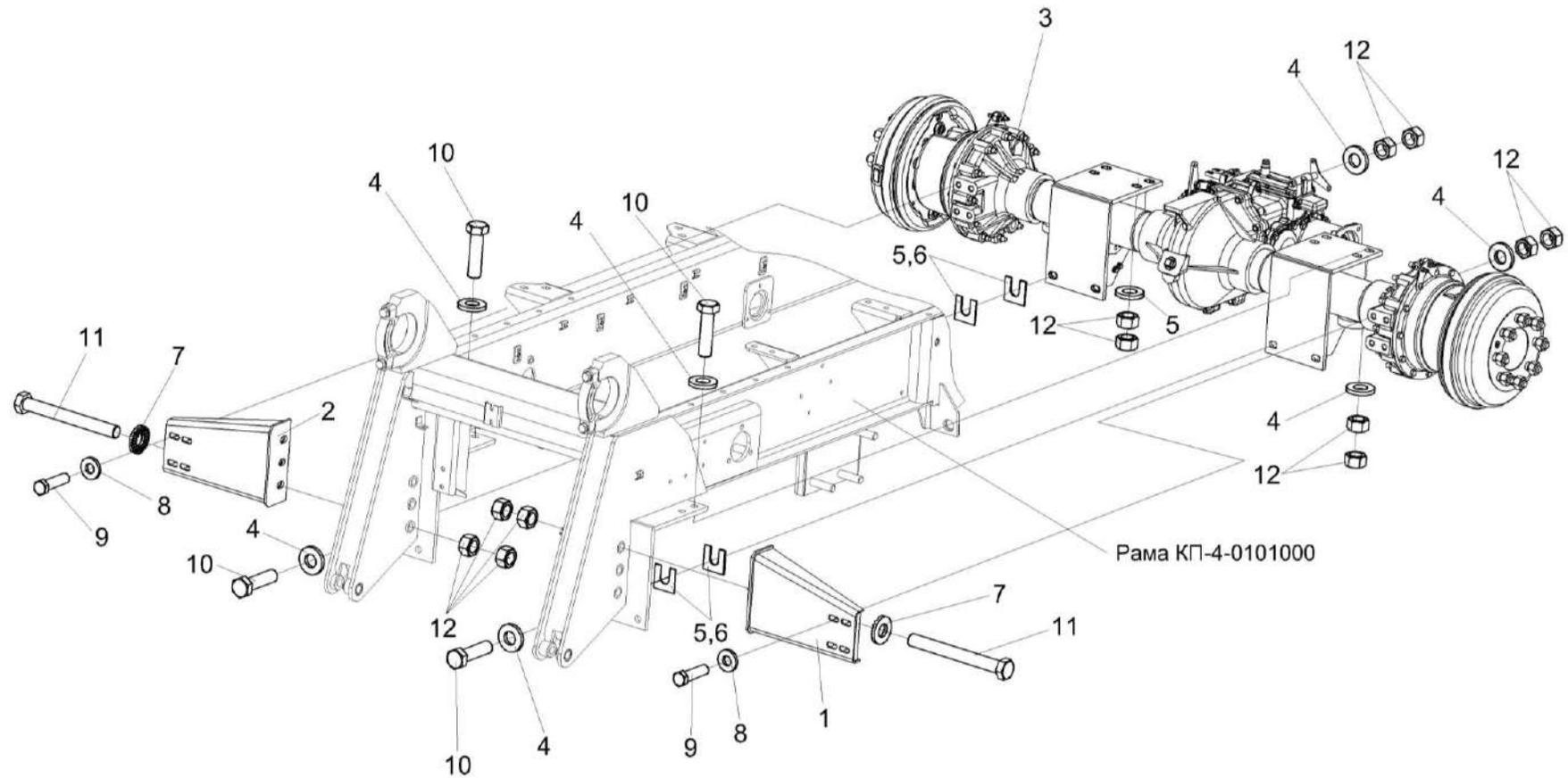
Рисунок 10 – Установка моста ведущих колес КПС-4-0107300
