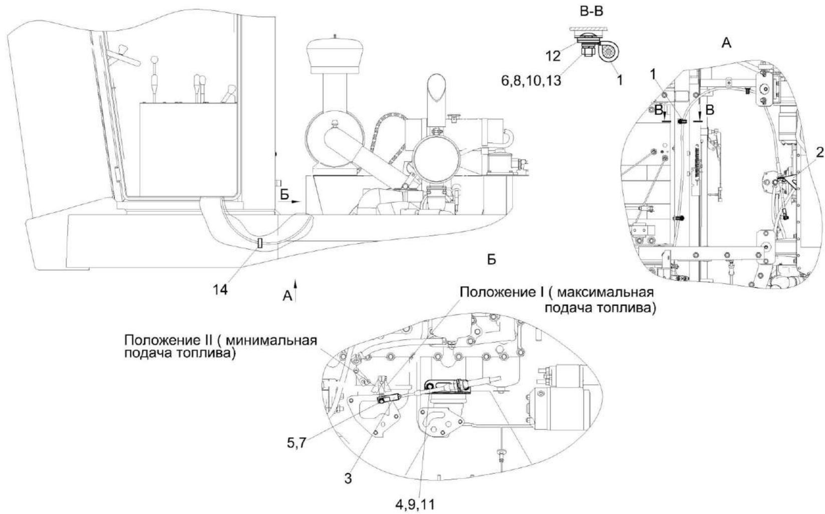
Рисунок 144 – Установка тросов двигателя КП-4-0119600А
