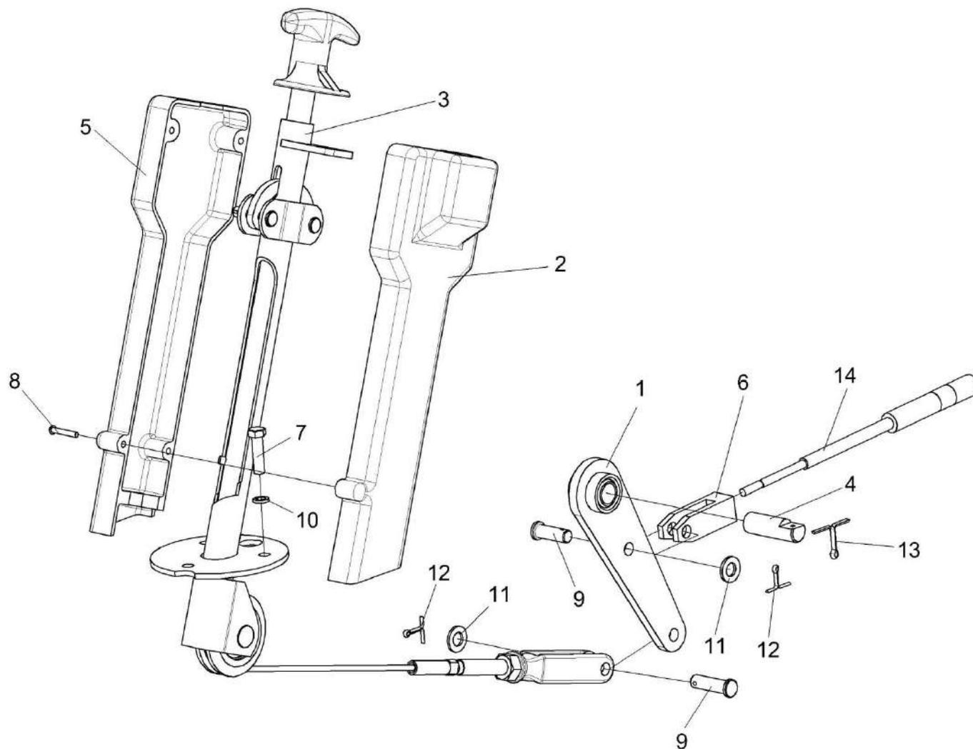
Рисунок 123 – Площадка управления КП-4-0119000-01. Установка колонки привода
