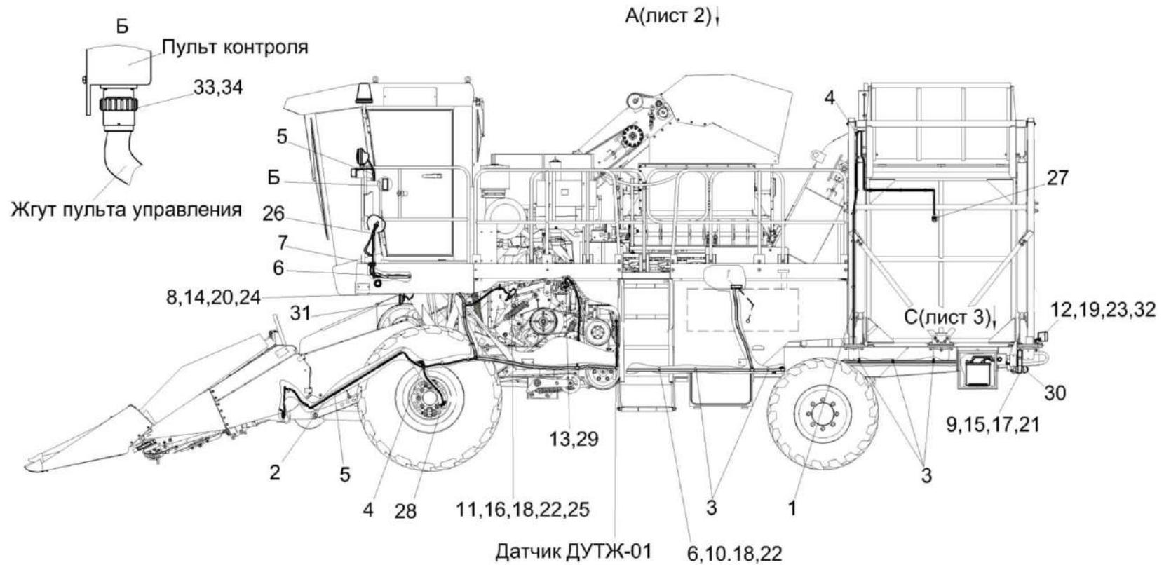
Рисунок 214 – Установка электрооборудования КП-4-0721000Б (лист 1)
