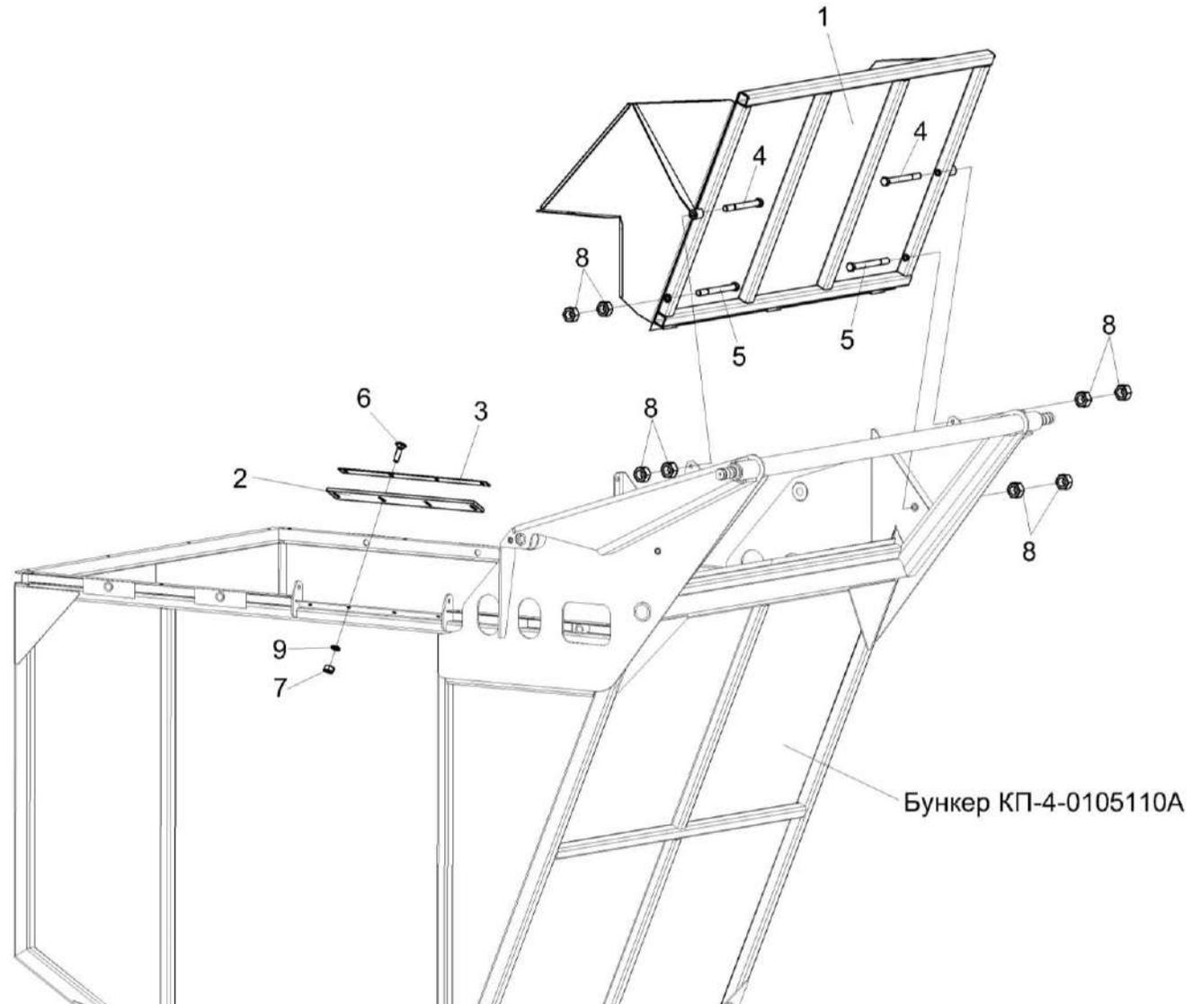
Рисунок 77 – Установка бункера КП-4-0105000Б (лист 4)
