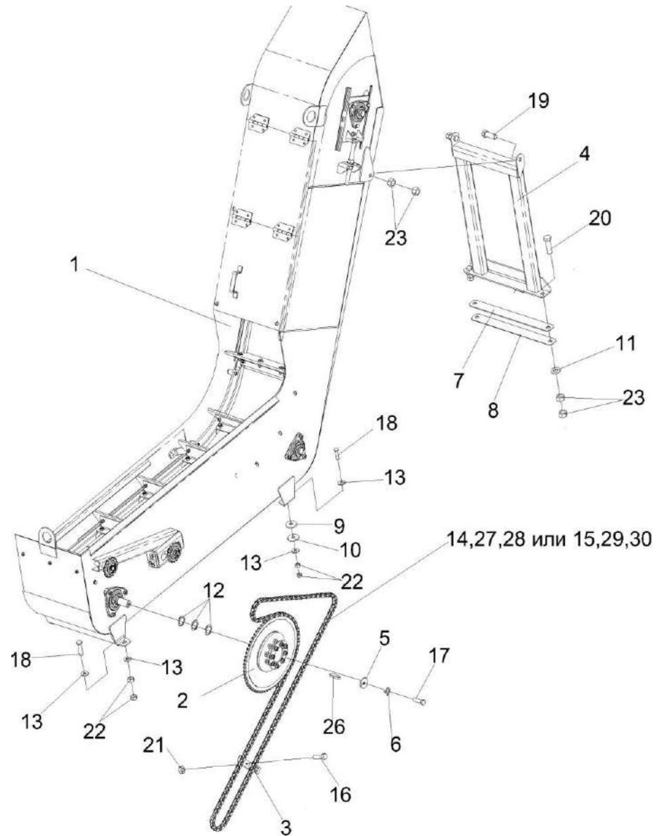
Рисунок 69 – Установка транспортера загрузочного КП-4-0104000А
