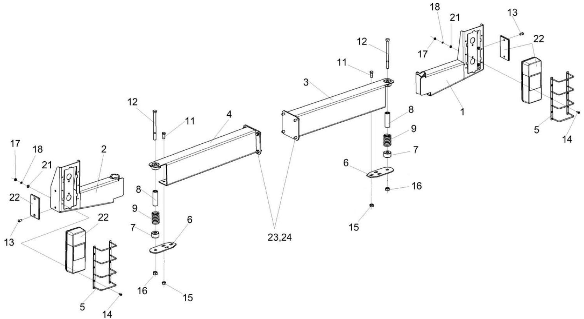
Рисунок 15 – Установка балки габаритной КП-4-0115000
