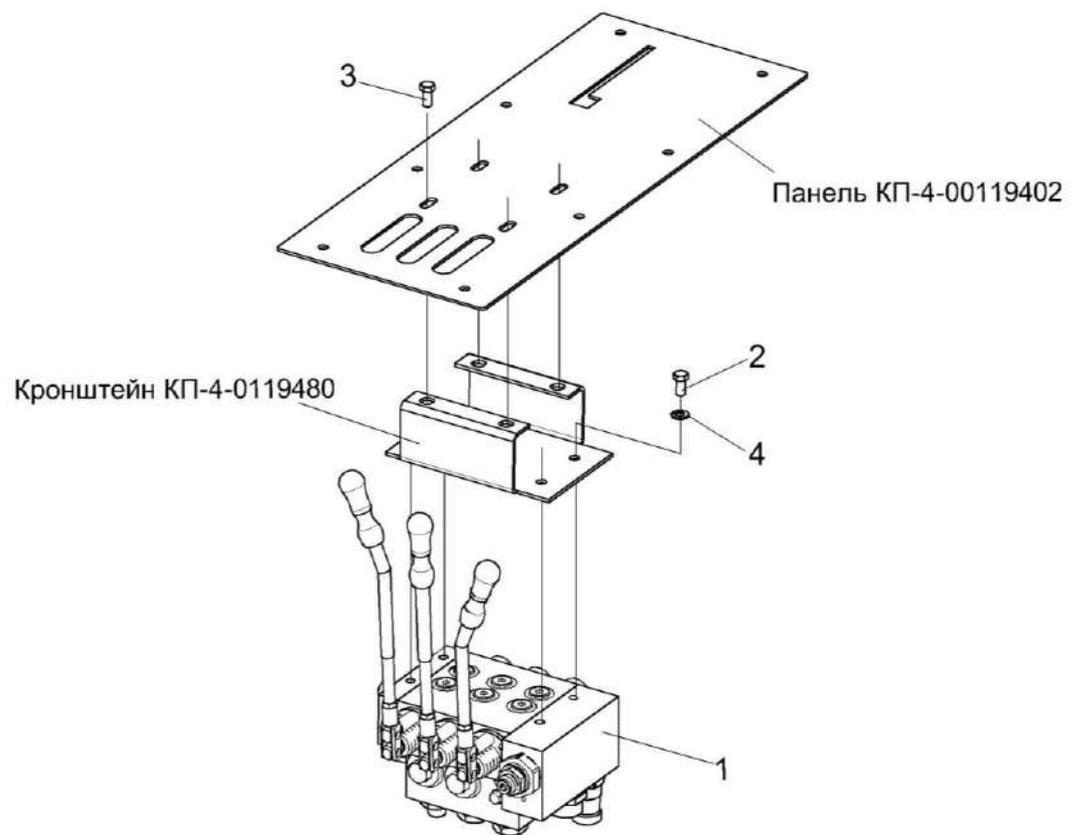
Рисунок 126 – Установка гидроблока КП-4-0600200
