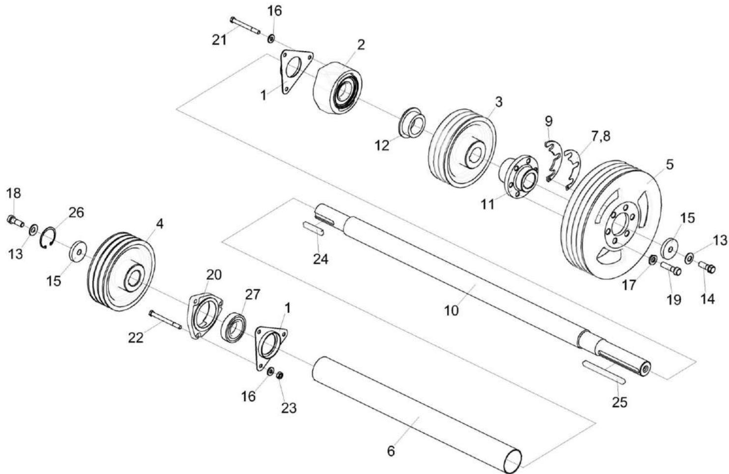
Рисунок 95 – Установка контрпривода главного КПС-4-0125600А (изменена конструкция)
