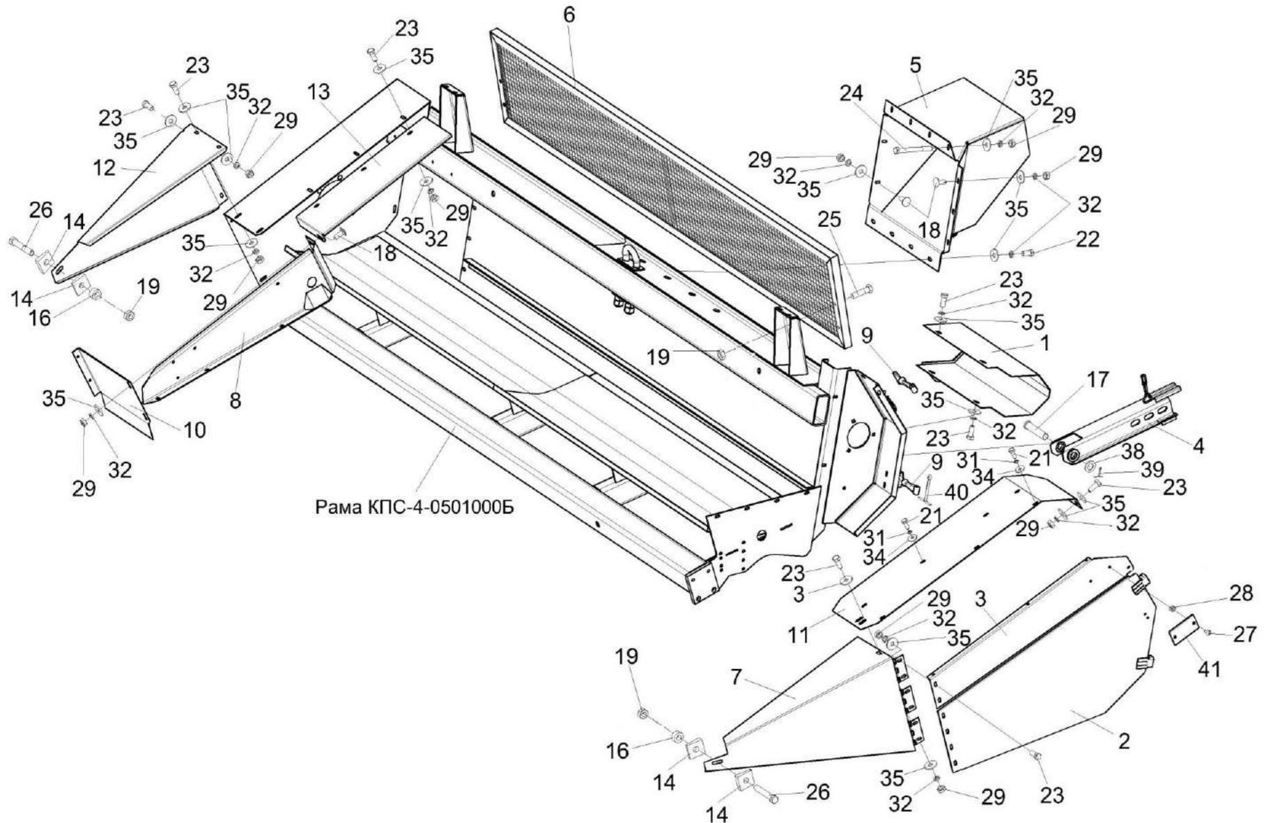
Рисунок 170 – Початкоотделитель КП-4-0500100 (щитки и ограждения)
