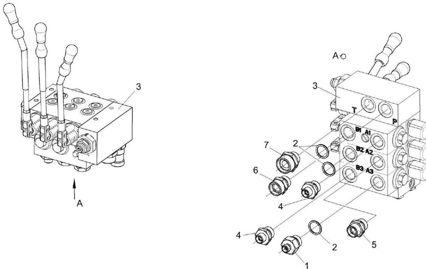
Рисунок 127 – Гидроблок трехсекционный КП-4-0600300
