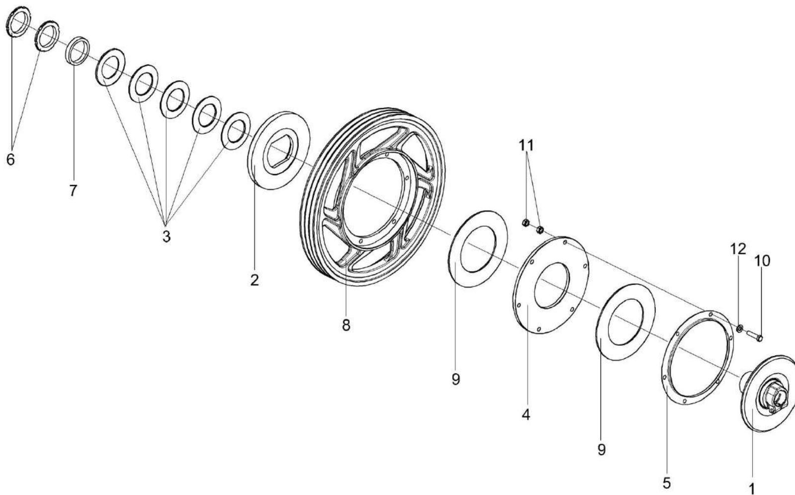
Рисунок 208 – Муфта предохранительная КЗК 1873100
