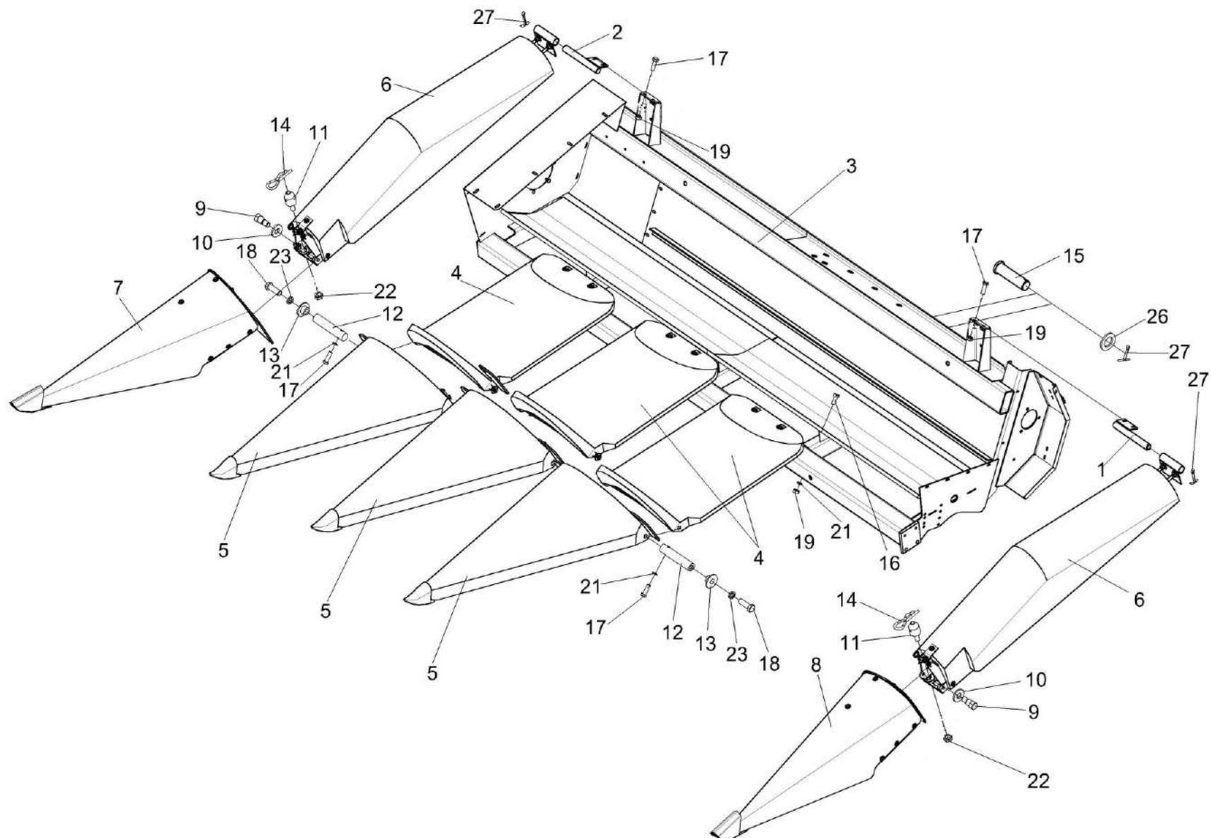
Рисунок 171 – Початкоотделитель КП-4-0500100 (установка кожухов делителей)
