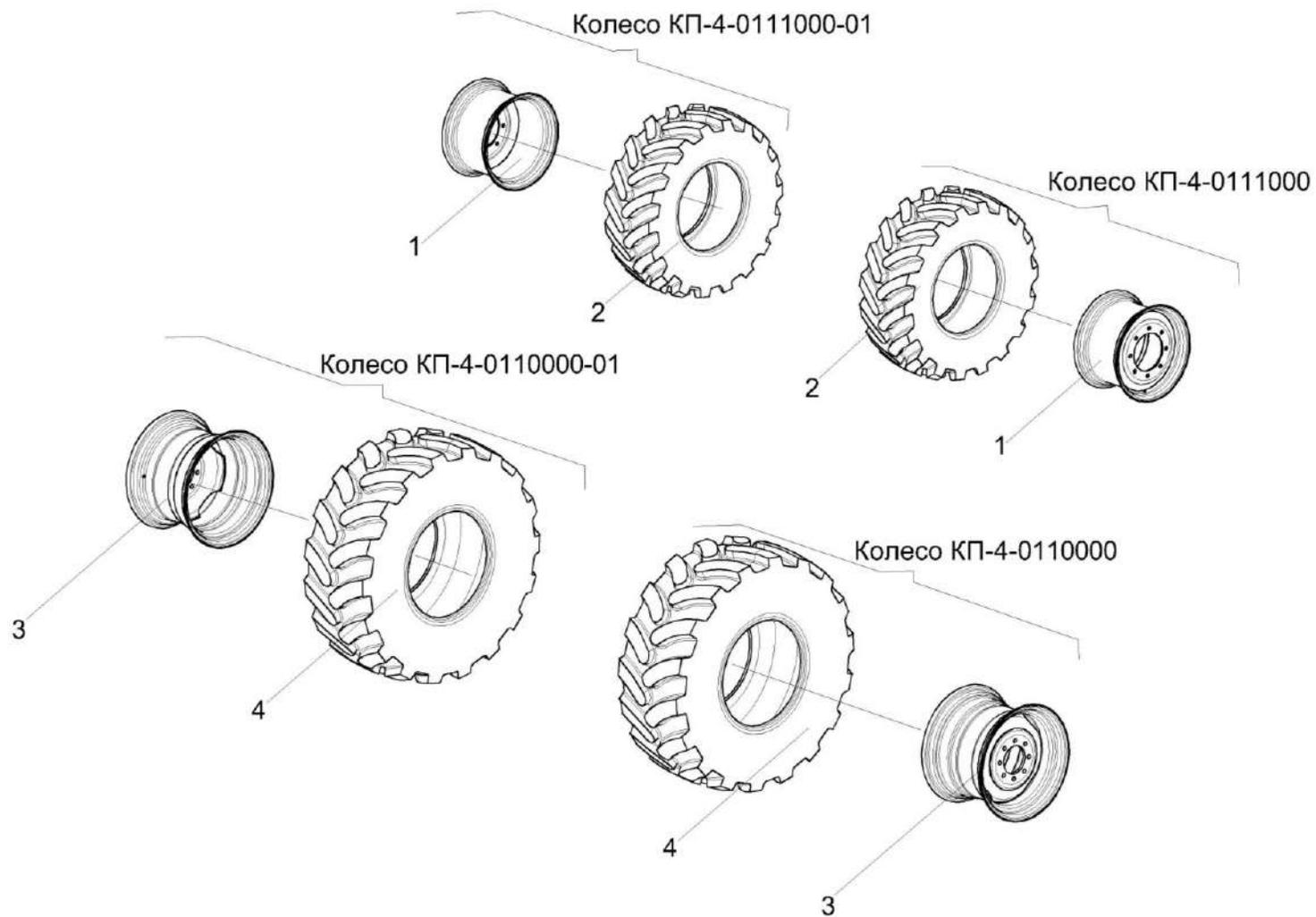
Рисунок 105 – Колеса комбайна
