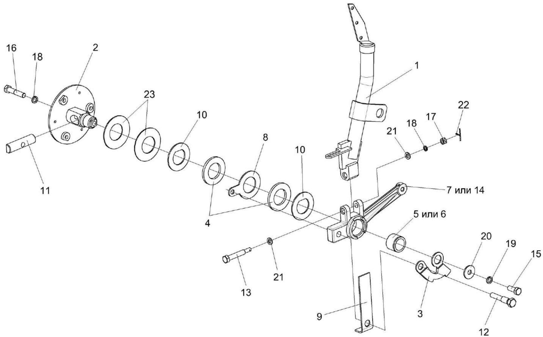
Рисунок 137 – Рычаг КЗК-12-0119920Б
