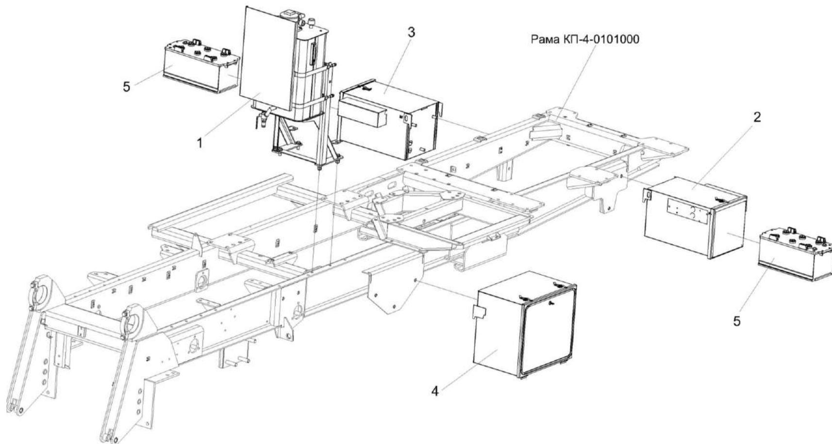
Рисунок 11 – Установка бака масляного, ящиков аккумуляторных и ящика инструментального
