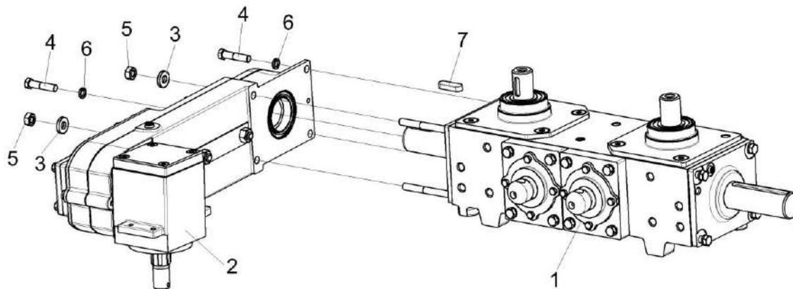
Рисунок 191 – Привод КПС-4-0518200
