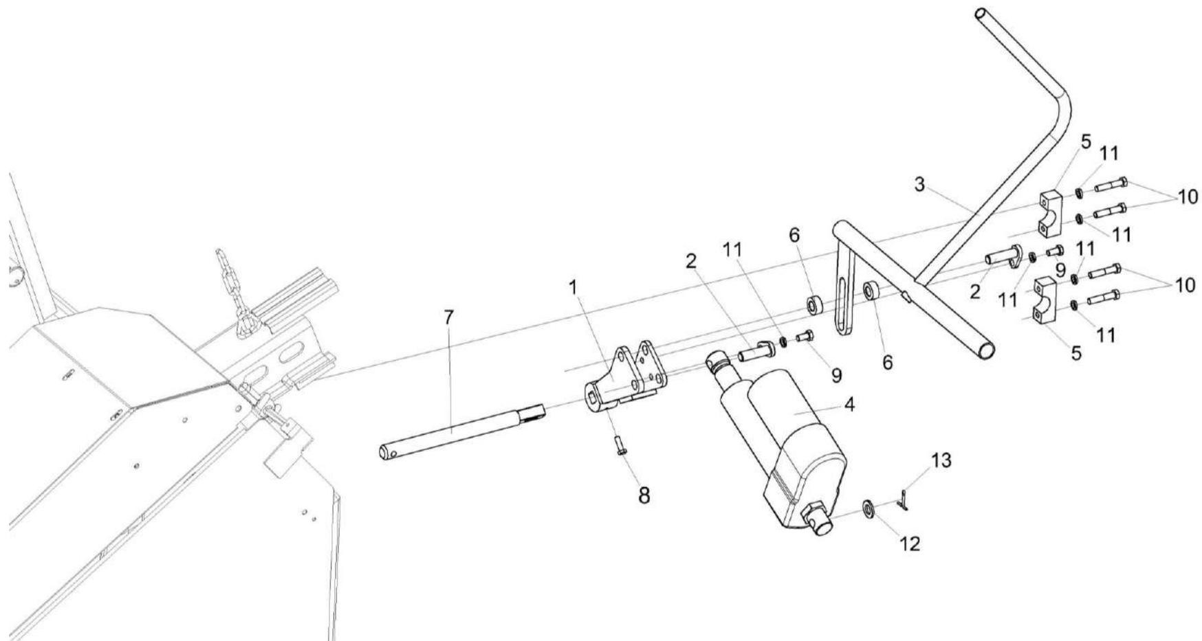
Рисунок 178 – Установка электромеханизма КП-4-0535000А
