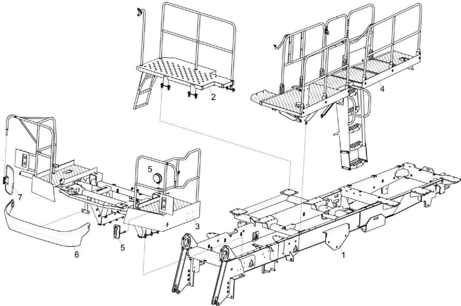
Рисунок 5 – Установка площадок комбайна початкоуборочного ES4
