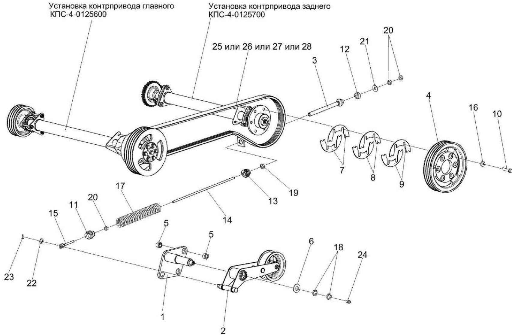
Рисунок 101 – Привод контрпривода заднего КПС-4-0125300А
