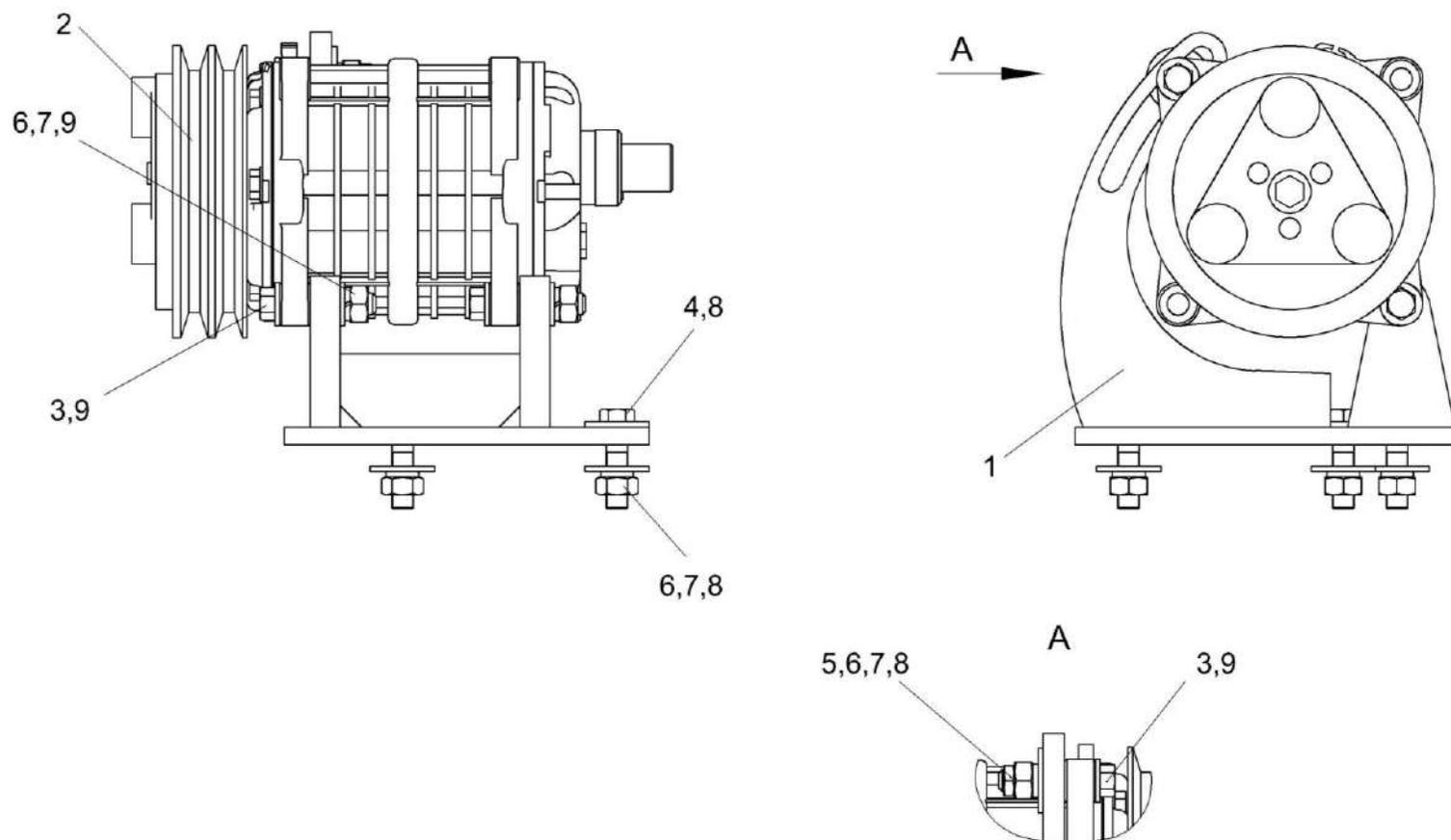
Рисунок 219 – Установка компрессора КП-4-0121030
