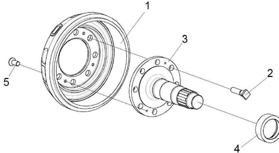
Рисунок 112 – Барабан с осью КЗК 0107090
