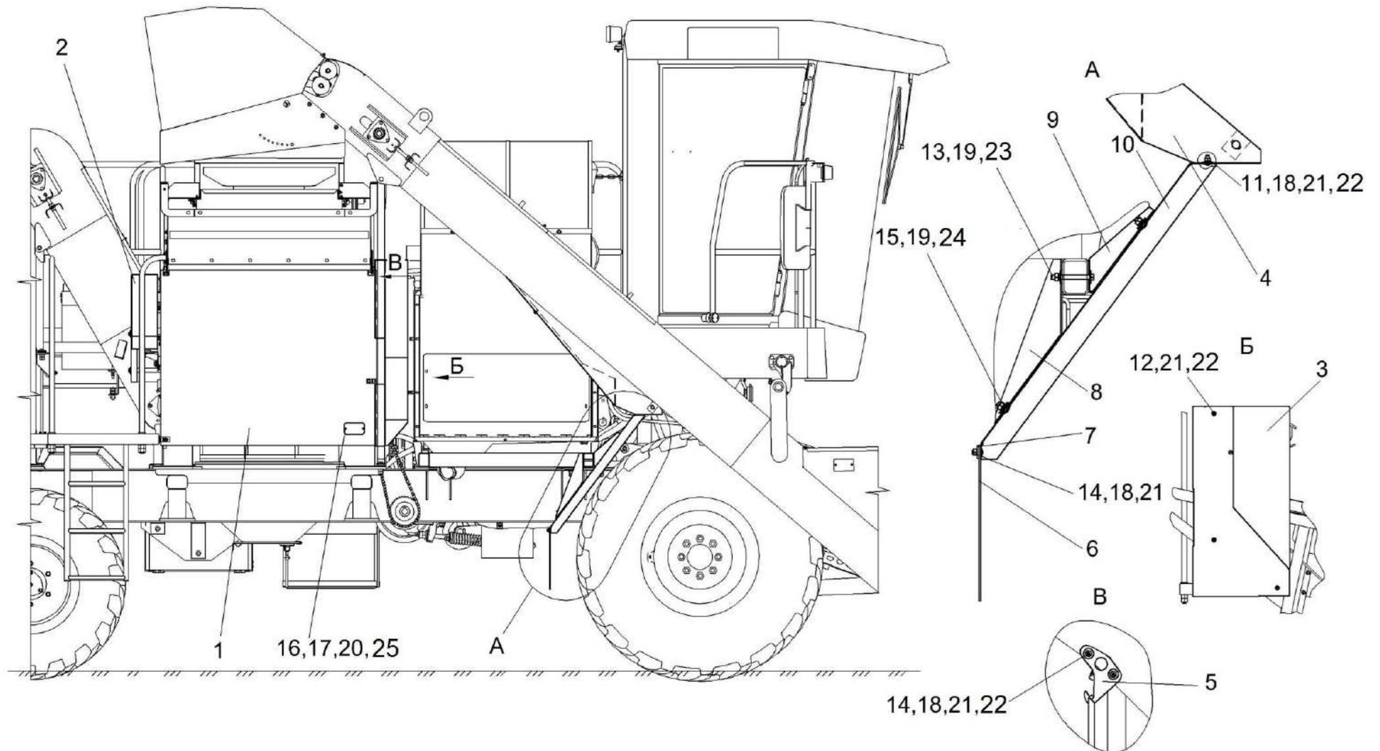
Рисунок 162 – Установка капотов КП-4-0128000 (лист 2)
