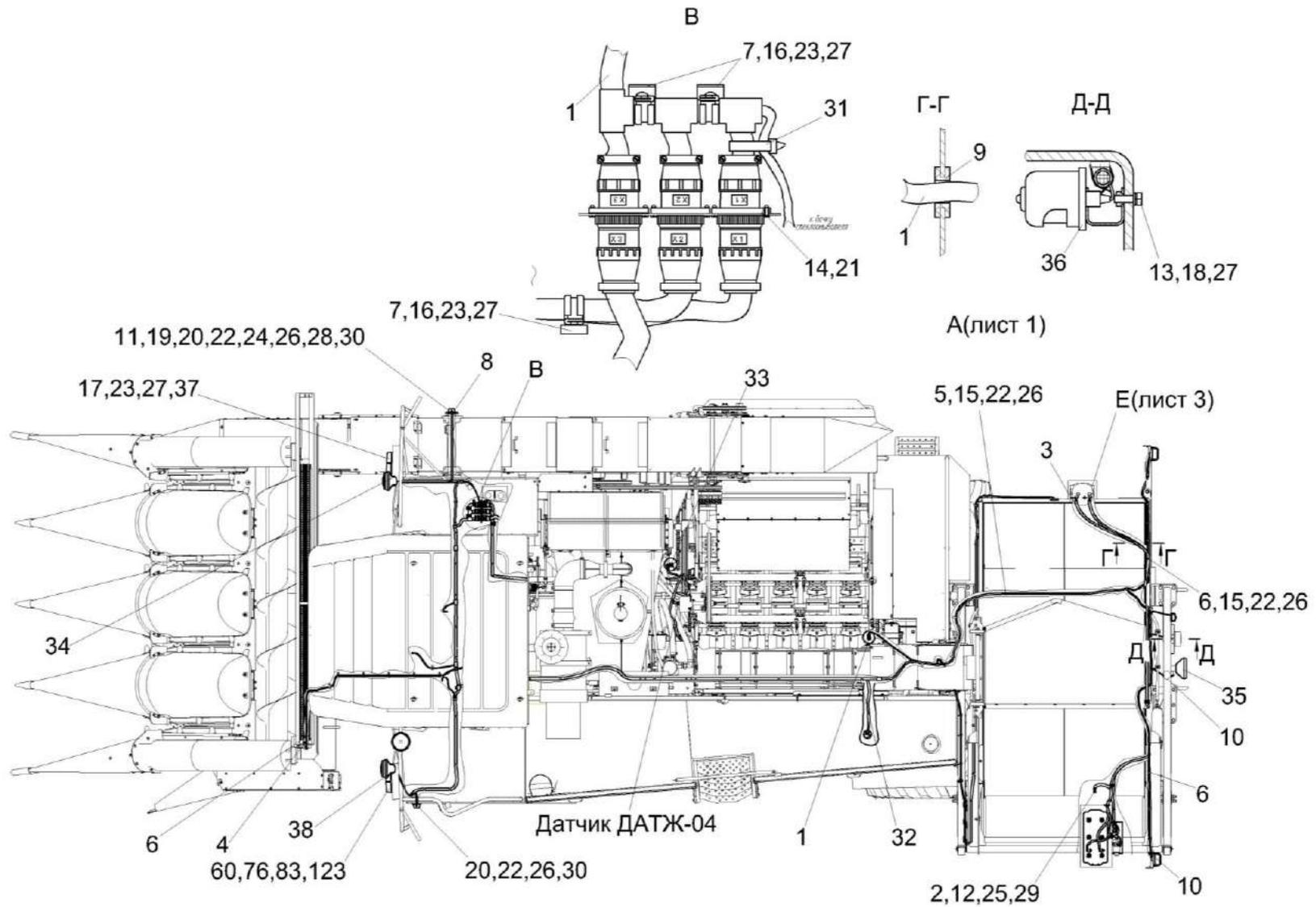
Рисунок 215 – Установка электрооборудования КП-4-0721000Б (лист 2)
