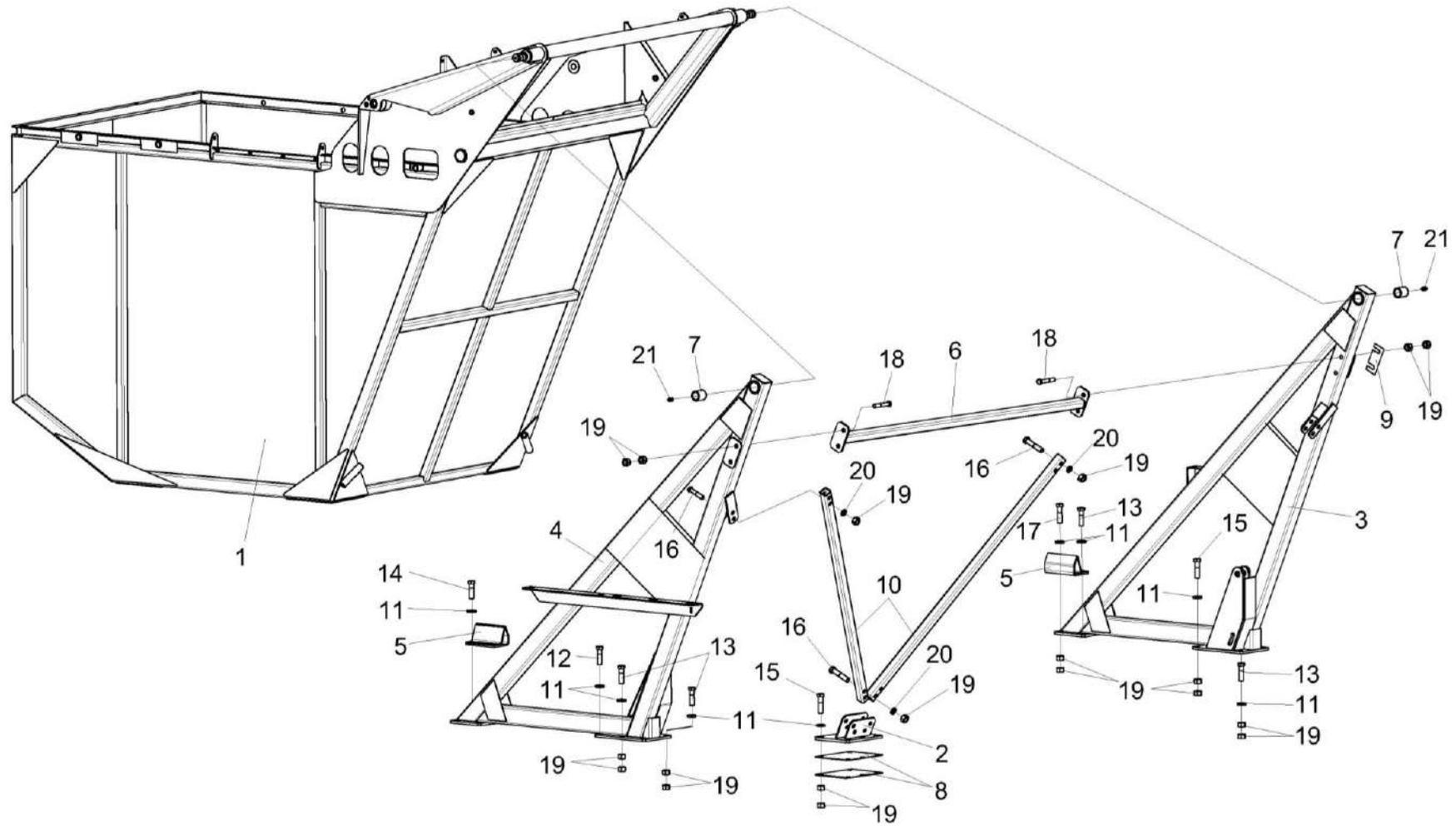
Рисунок 75 – Установка бункера КП-4-0105000Б (лист 2)
