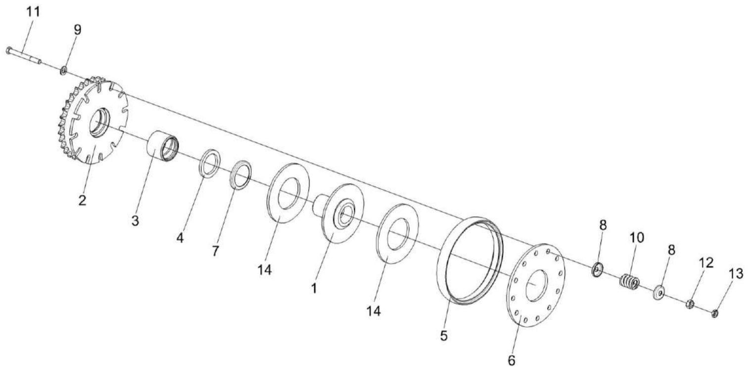
Рисунок 67 – Муфта фрикционная КП-4-0103360
