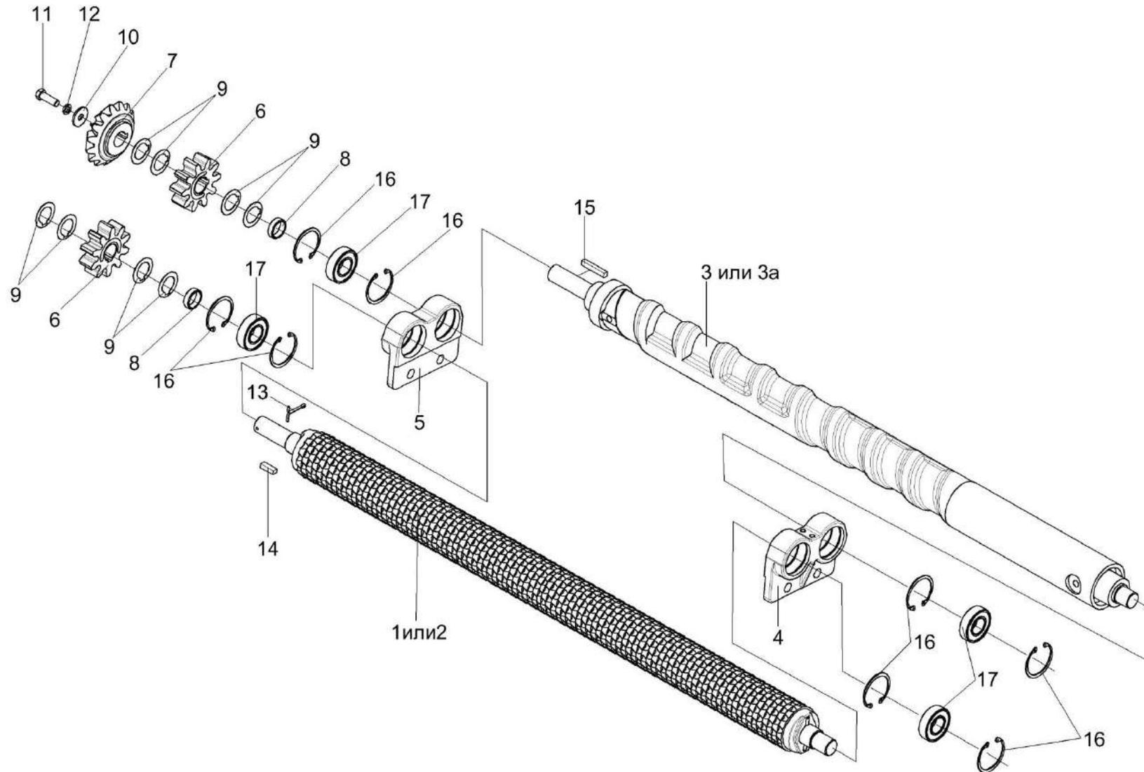
Рисунок 32 – Установка вальцов блока вальцов КП-4-0102430
