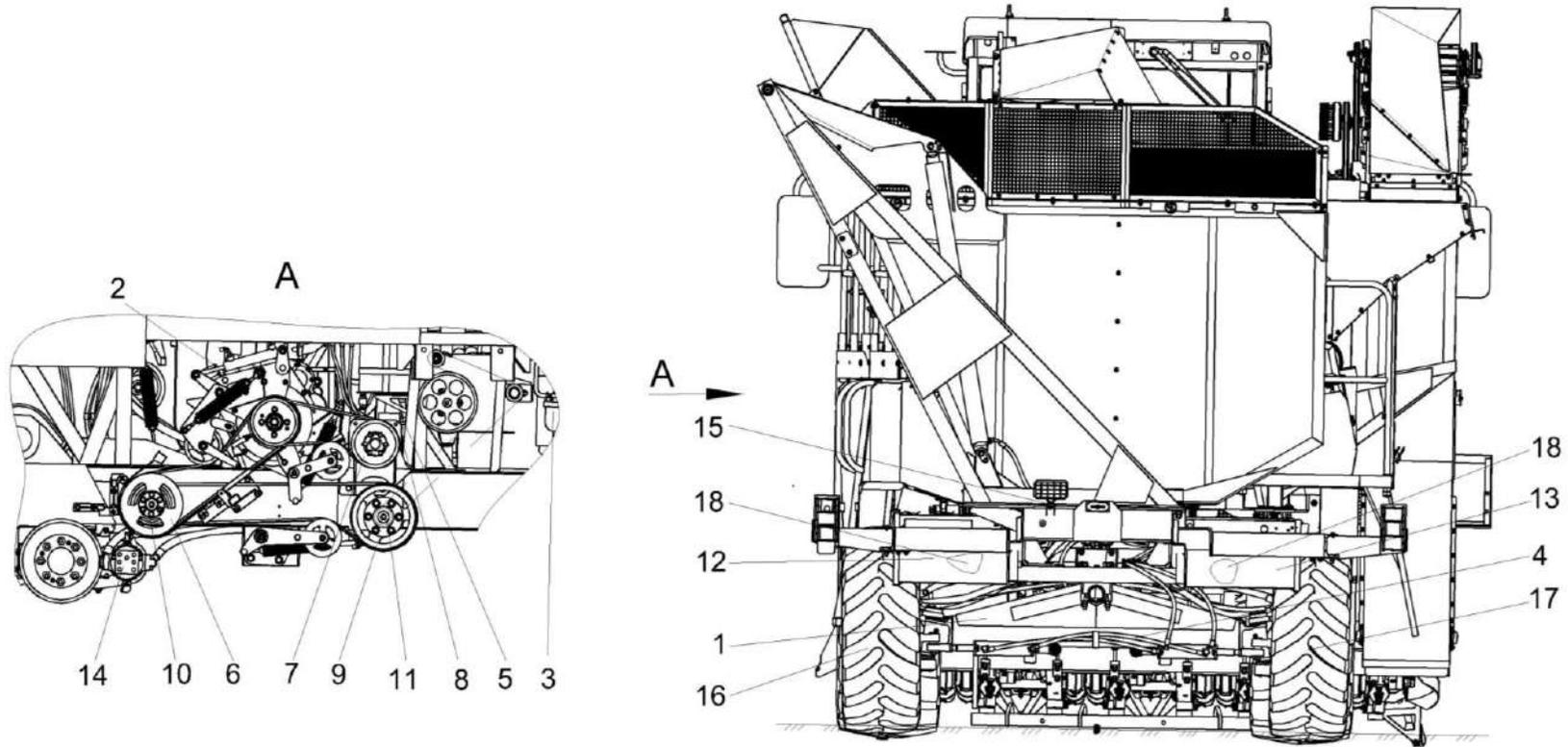
Рисунок 4 – Комбайн пшеничноуборочный ES4 КП-4-0000000Б-01 (вид сзади)
