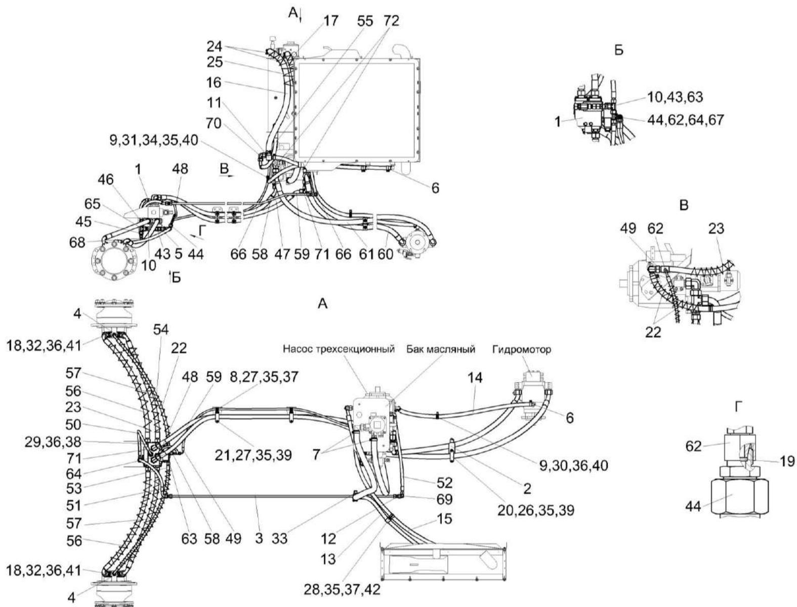
Рисунок 211 – Гидросистема привода ходовой части КП-4-0605000
