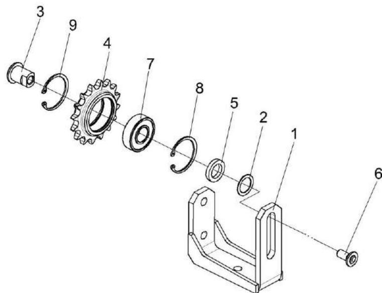
Рисунок 183 – Устройство натяжное КПС-4-0523000
