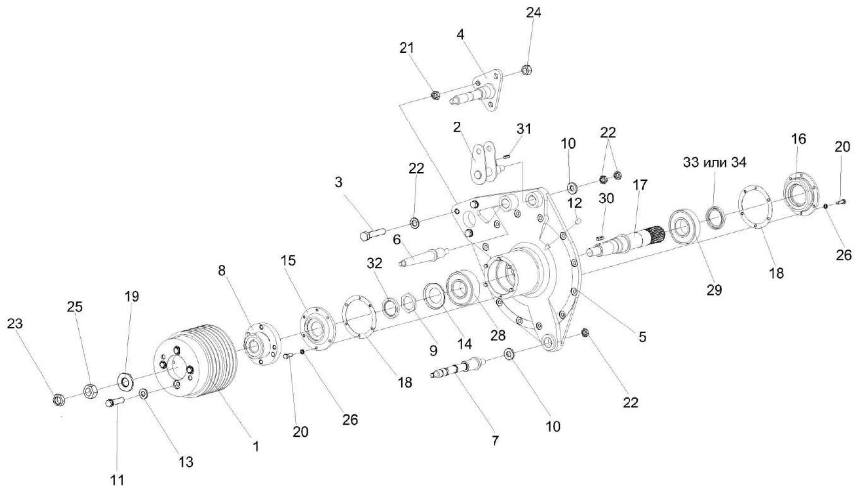
Рисунок 84 – Установка вала главного привода КП-4-0106120
