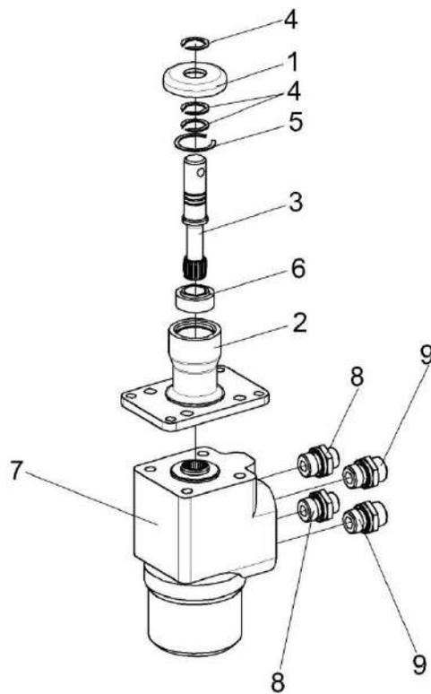
Рисунок 133 – Установка насоса-дозатора КП-4-0600100
