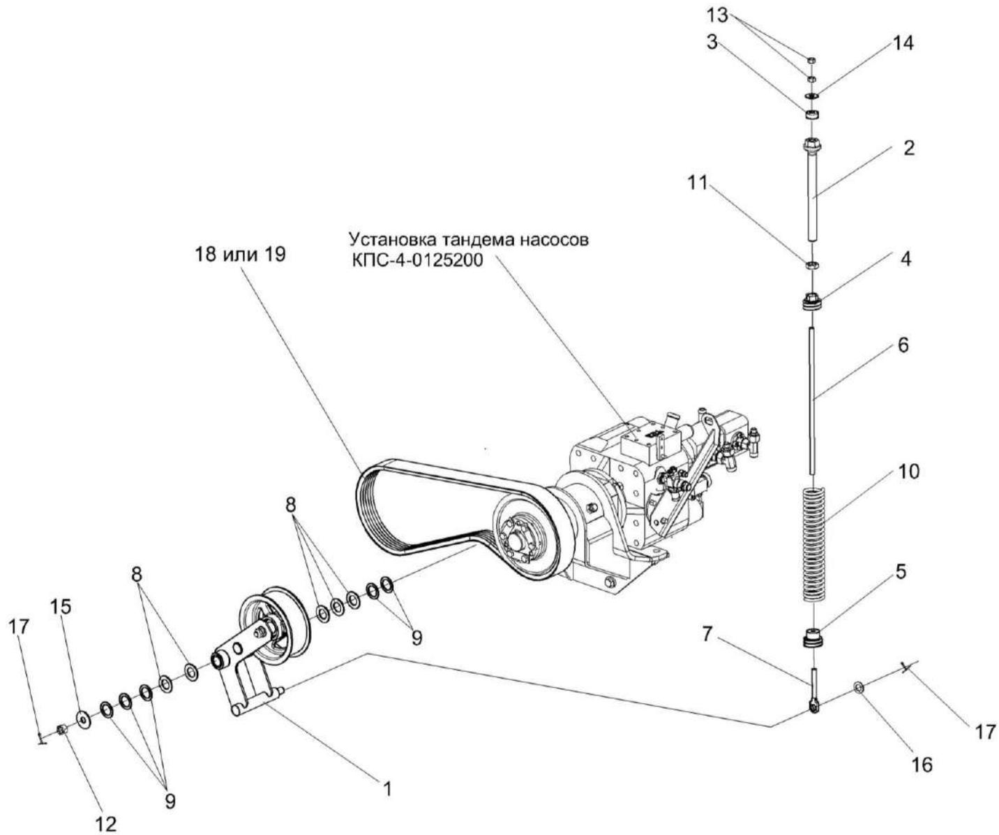
Рисунок 96 – Привод тандема насосов КПС-4-0125100
