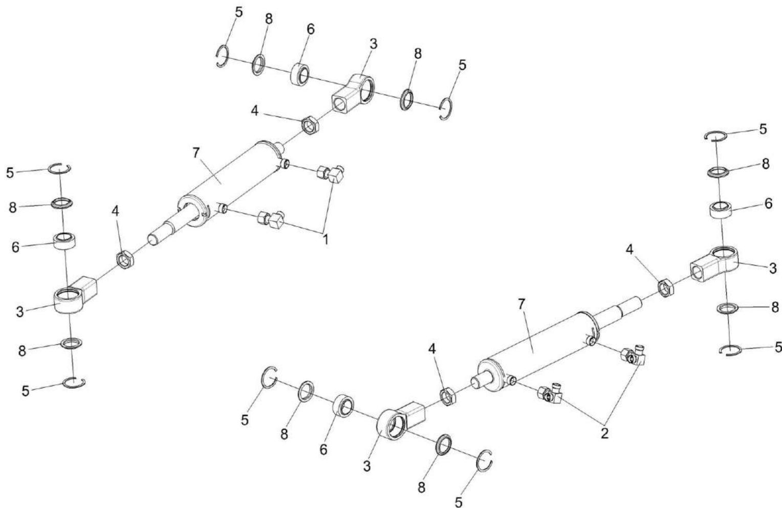
Рисунок 121 – Гидроцилиндры КПС-5-0602510 и КПС-5-0602510-01
