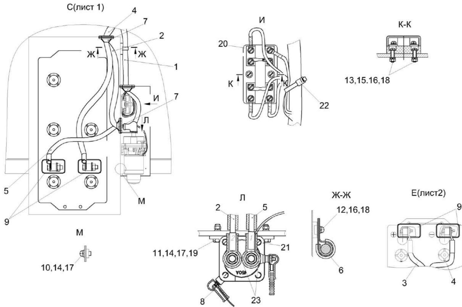
Рисунок 216 – Установка электрооборудования КП-4-0721000Б (лист 3)
