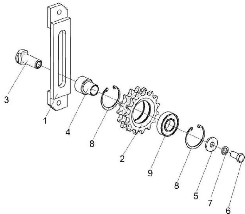
Рисунок 184 – Устройство натяжное КПС-4-0524000
