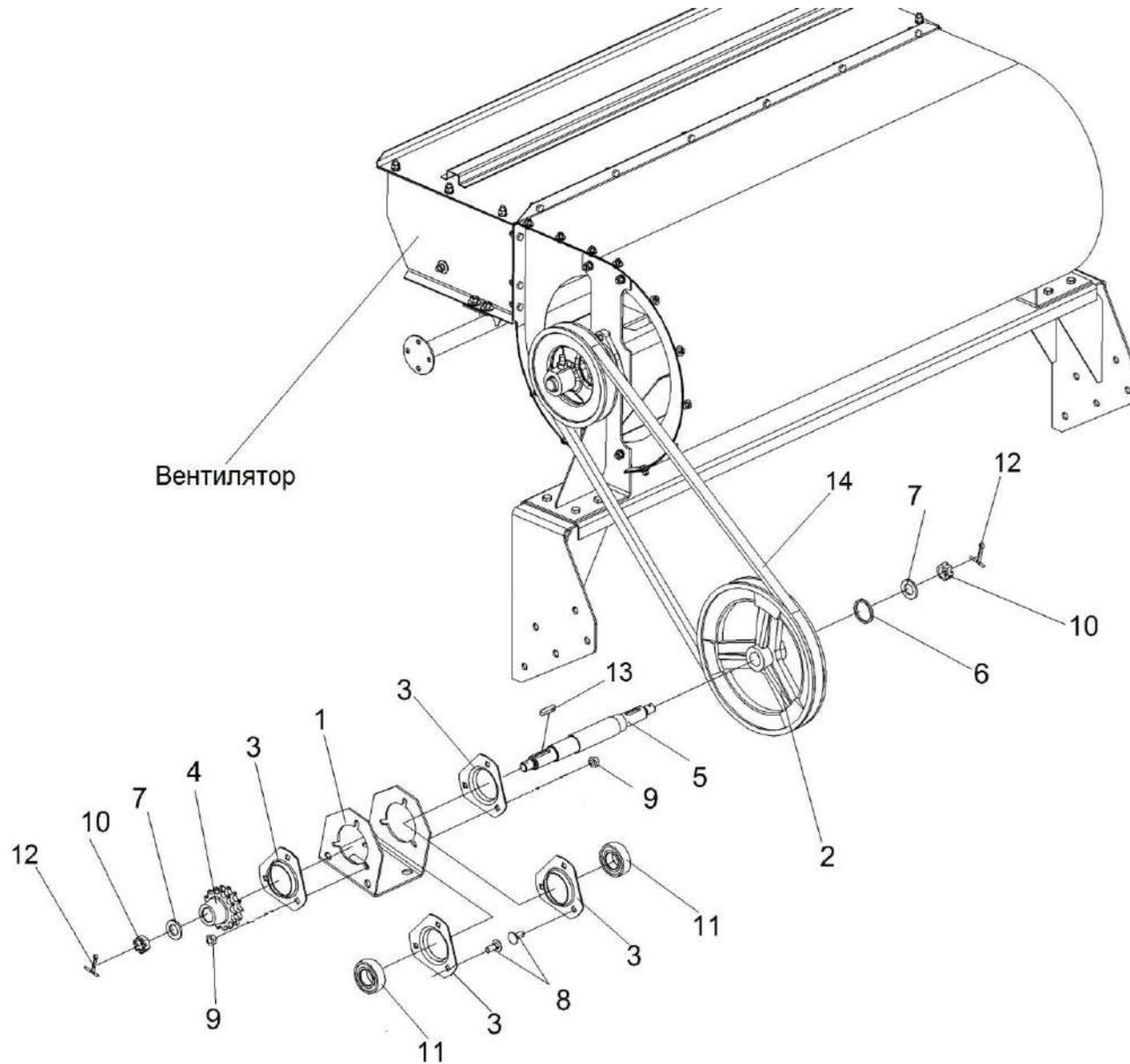
Рисунок 51– Контрпривод вентилятора КПС-4-0102800А
