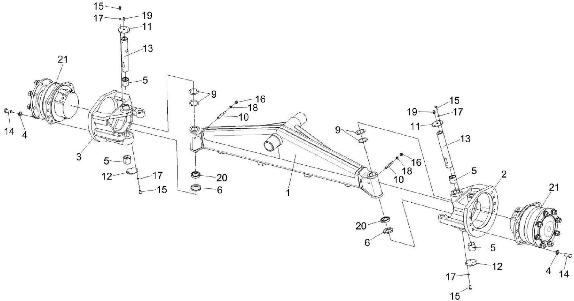
Рисунок 118 – Мост управляемых колес КП-4-0109000. Установка кулаков поворотных
