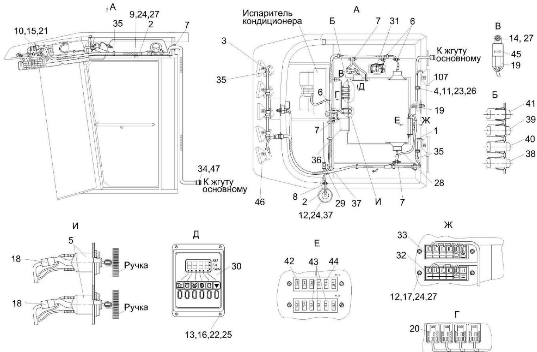
Рисунок 160 – Установка электрооборудования кабины КП-4-0722000В
