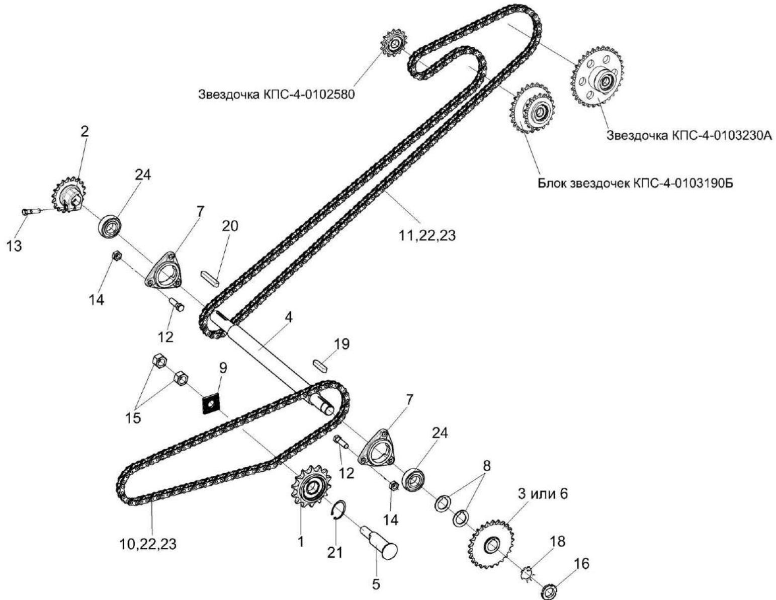
Рисунок 68 – Привод транспортера переднего КПС-4-0125500А
