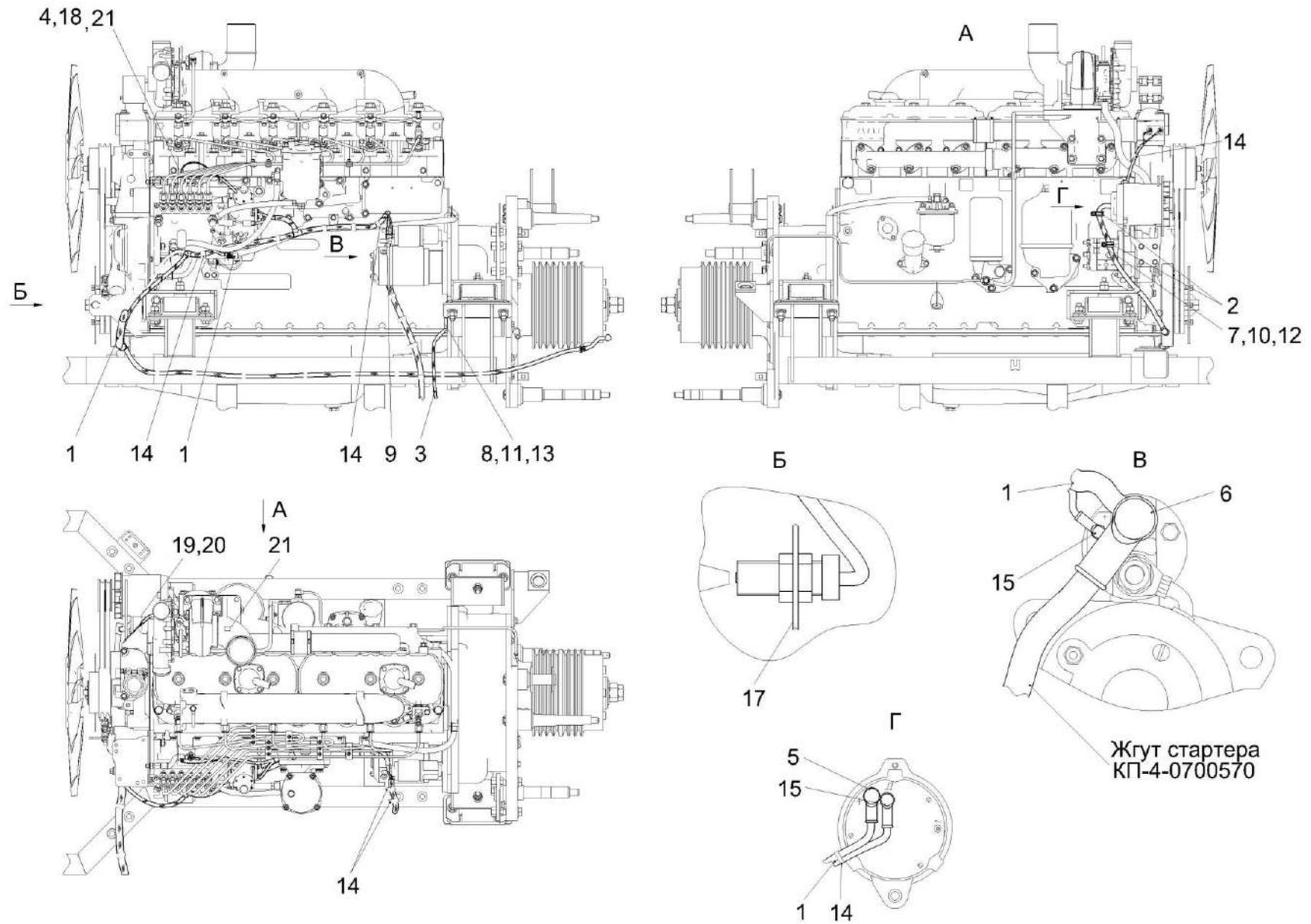
Рисунок 91 – Установка электрооборудования моторной установки КП-4-0726000Б
