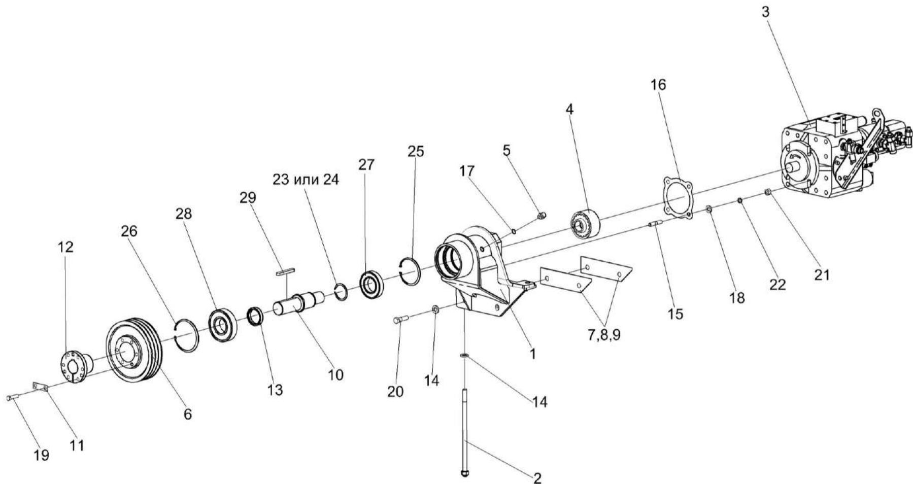
Рисунок 98 – Установка тандема насосов КПС-4-0125200
