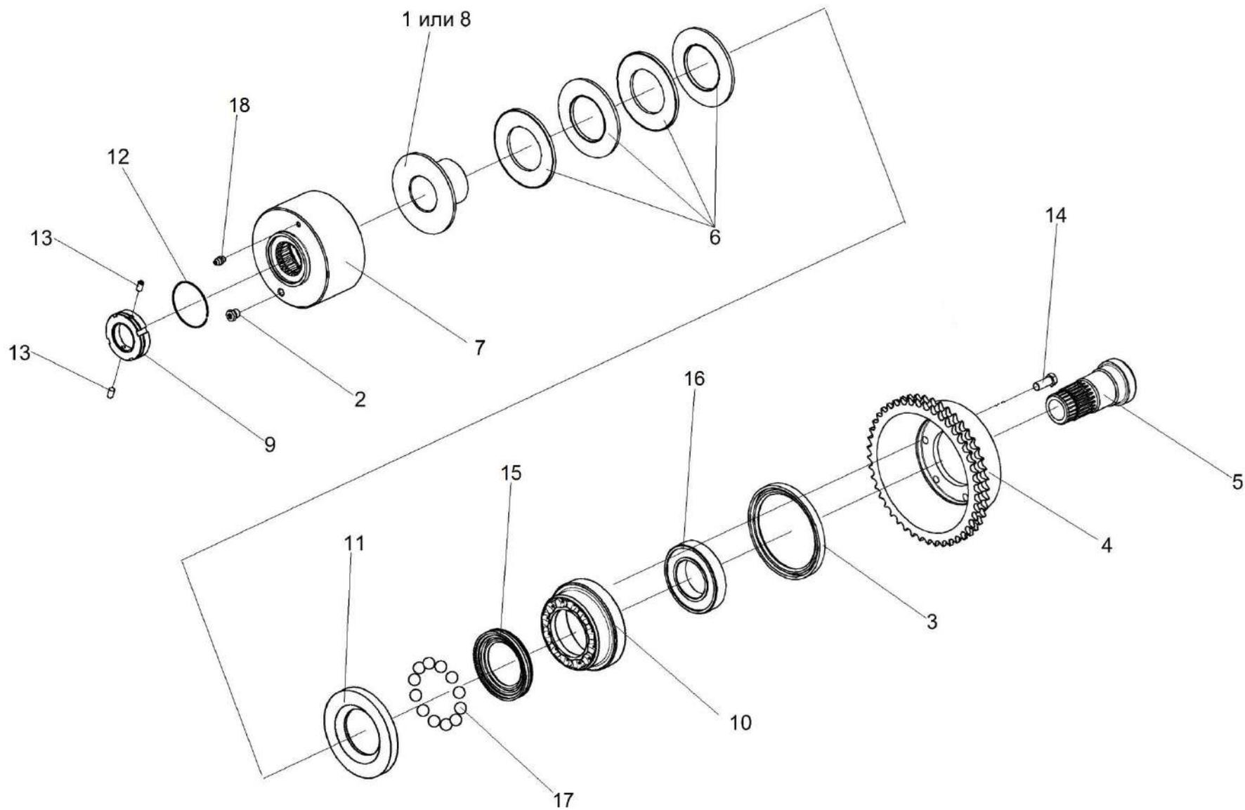
Рисунок 52 – Муфта предохранительная КПС-4-0102990
