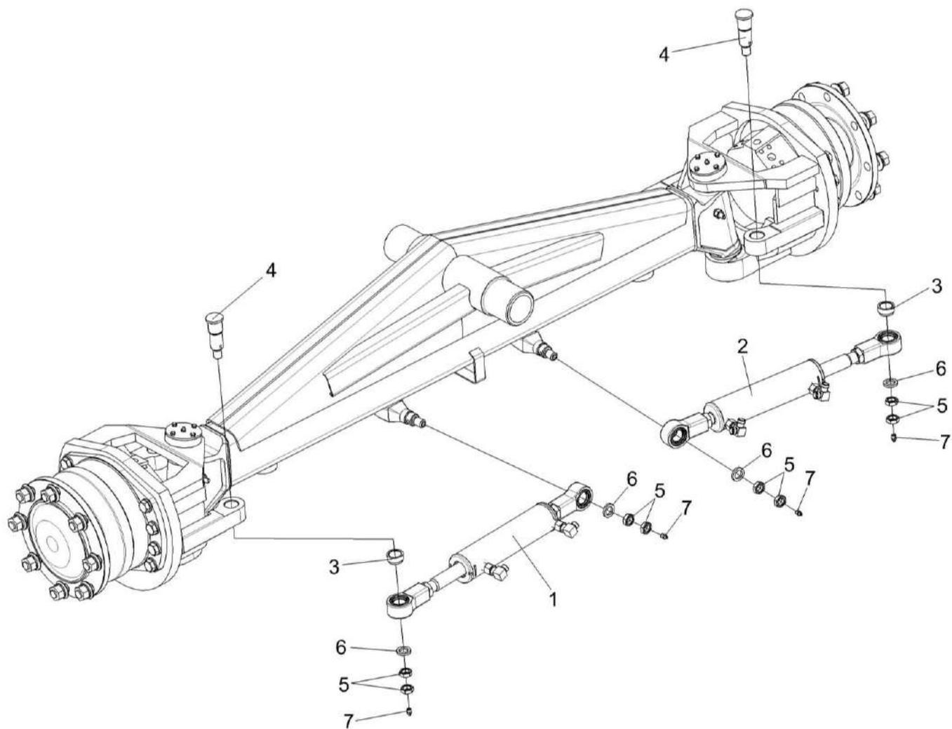
Рисунок 120 – Мост управляемых колес КП-4-0109000. Установка гидроцилиндров
