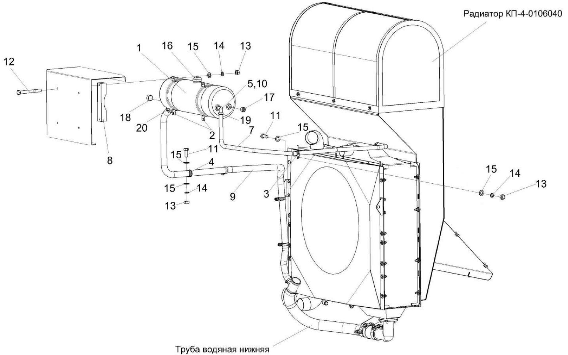
Рисунок 88 – Установка бачка расширительного КП-4-0106070
