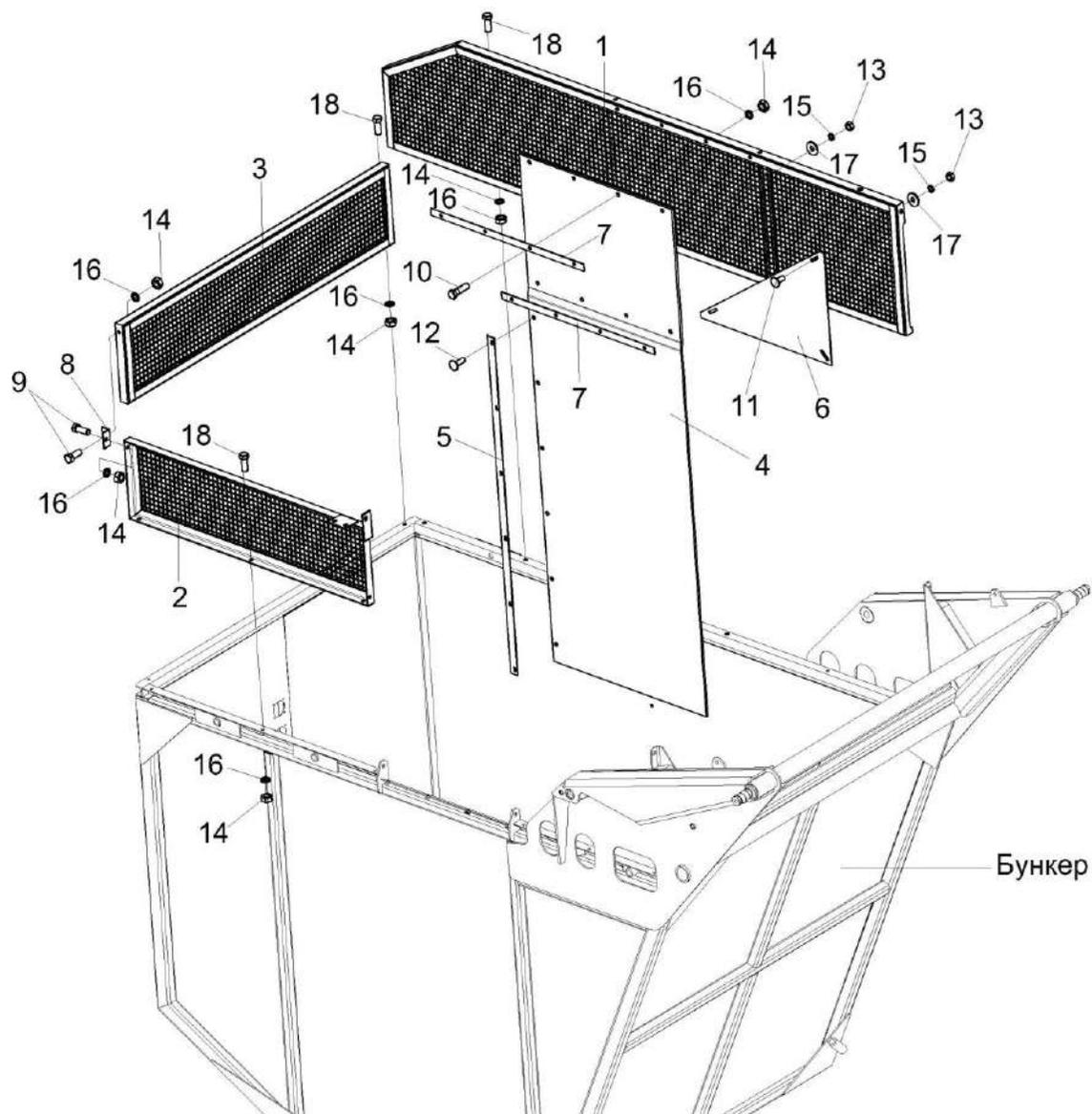
Рисунок 78 – Установка бункера КП-4-0105000Б (лист 5)
