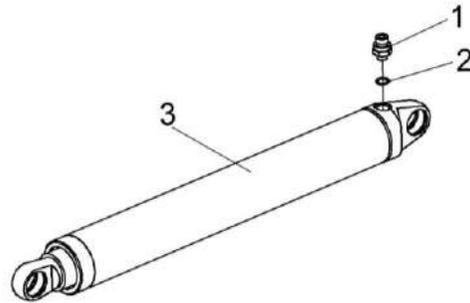
Рисунок 212 – Гидроцилиндр КПС-4-0600530
