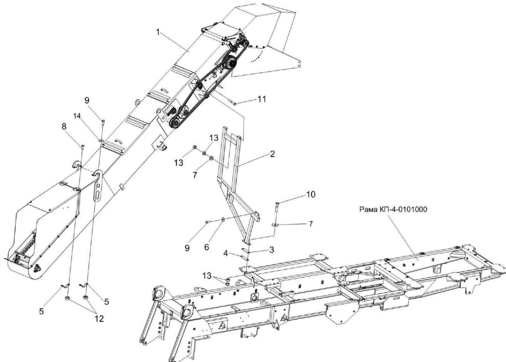
Рисунок 58 – Установка транспортера переднего КП-4-0103000Б
