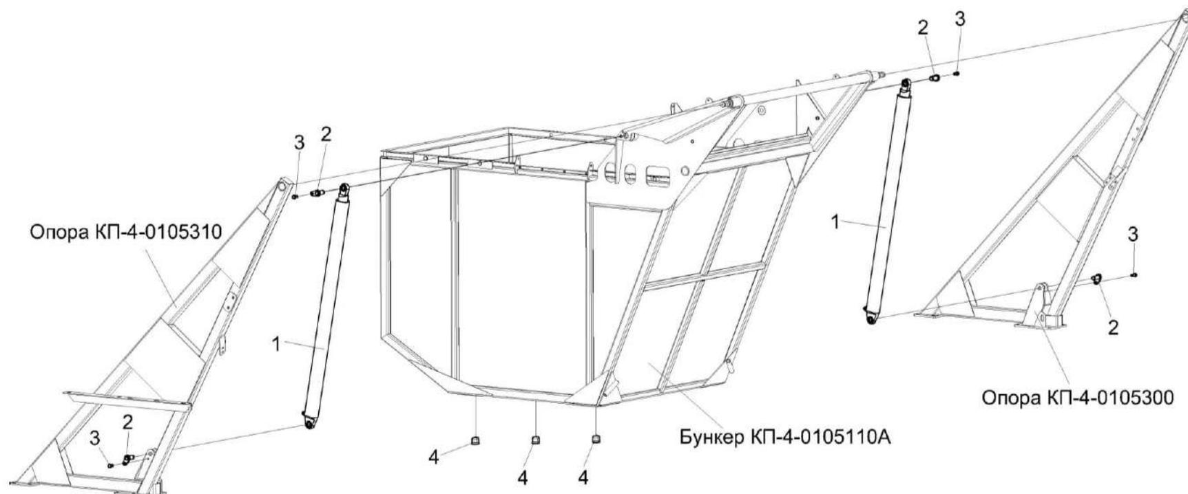
Рисунок 76 – Установка бункера КП-4-0105000Б(лист 3)
