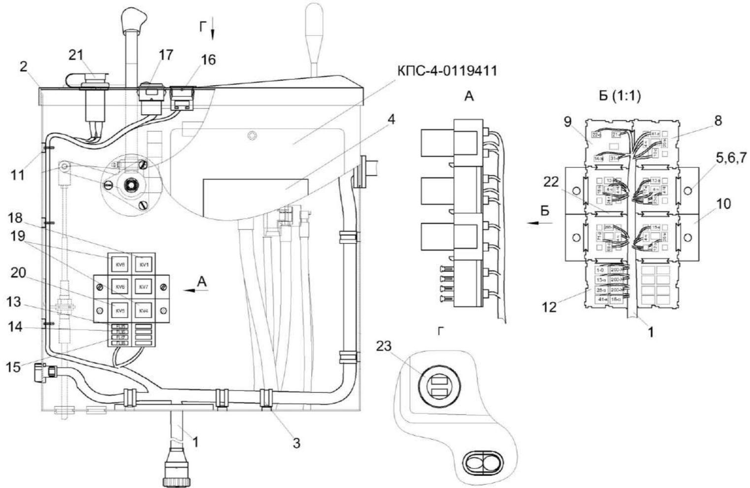
Рисунок 129 – Установка электрооборудования пульта КП-4-0725000Б-01
