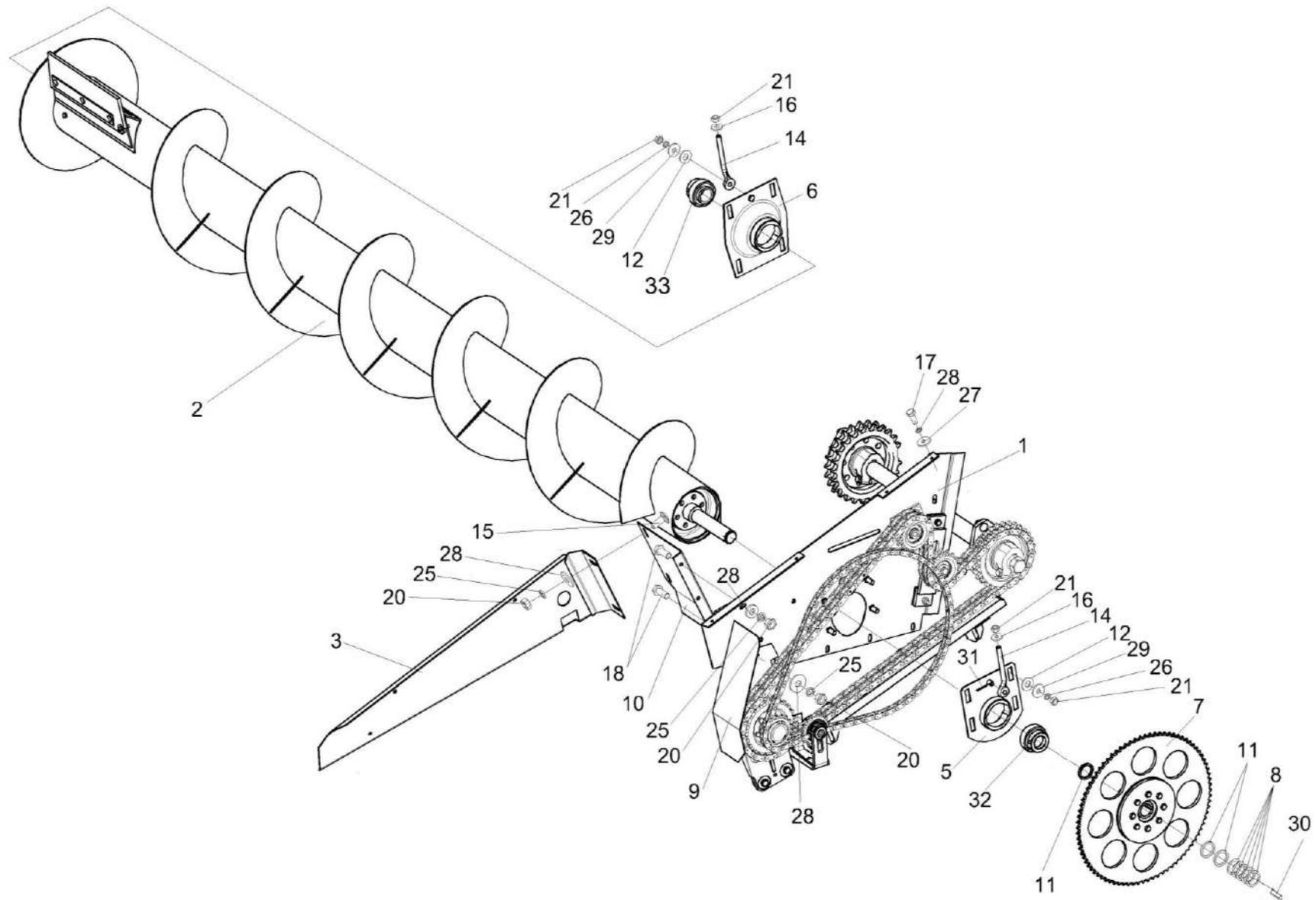
Рисунок 172 – Початкоотделитель КП-4-0500100 (установка шнека КП-4-0502000)
