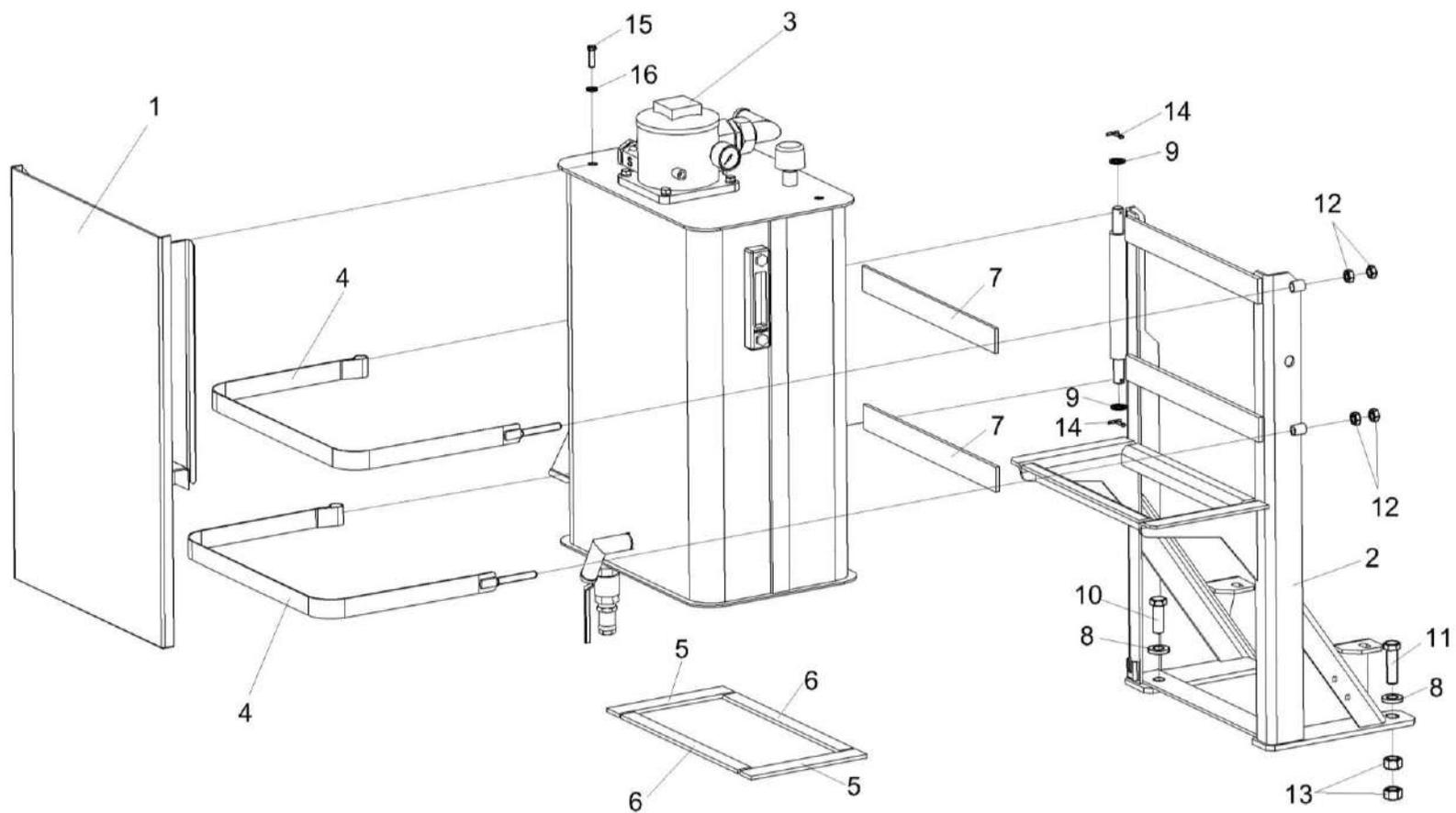
Рисунок 12 – Установка бака масляного КП-4-0127000
