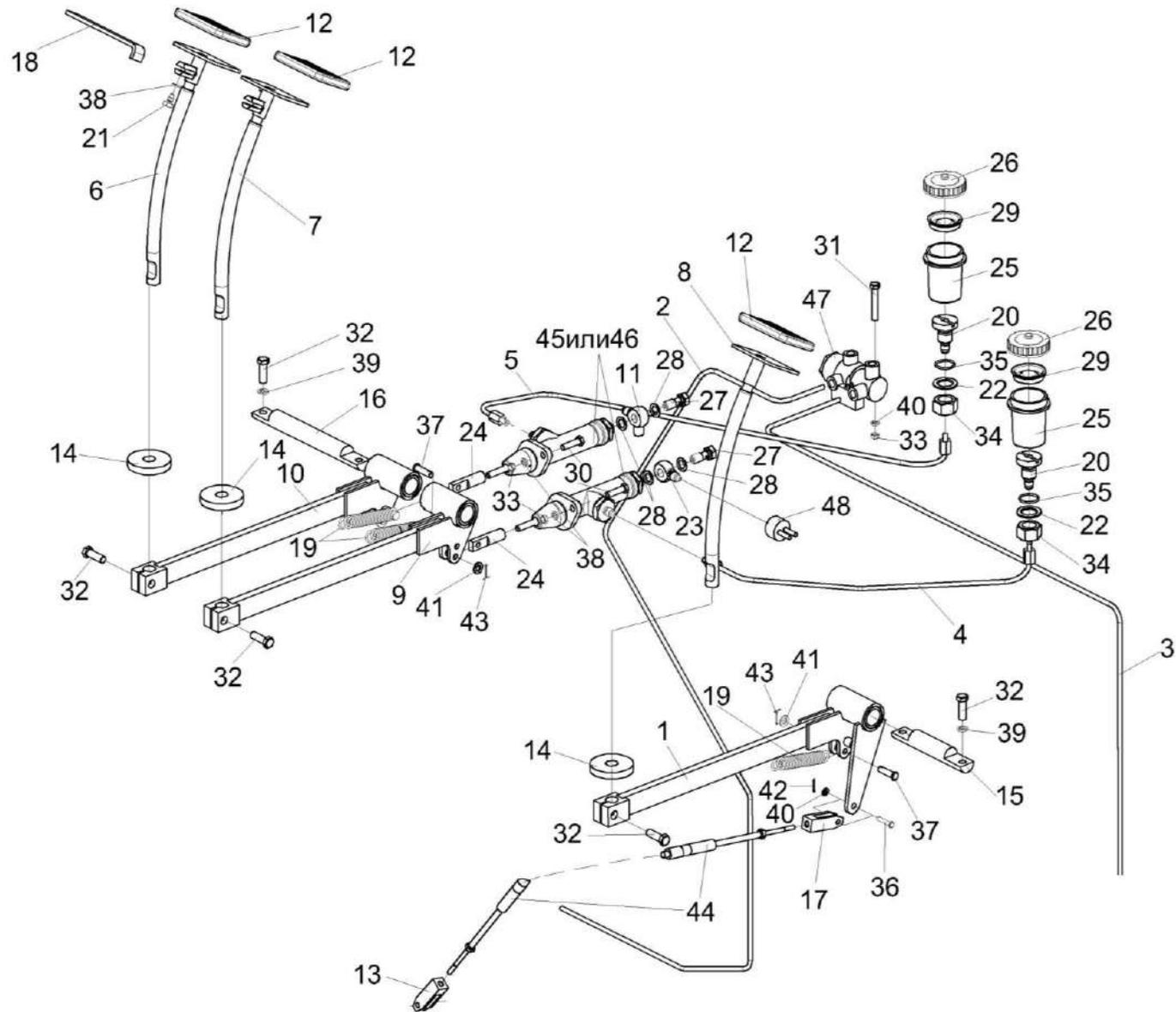
Рисунок 124 – Площадка управления КП-4-0119000-01. Рычаги и трубопроводы
