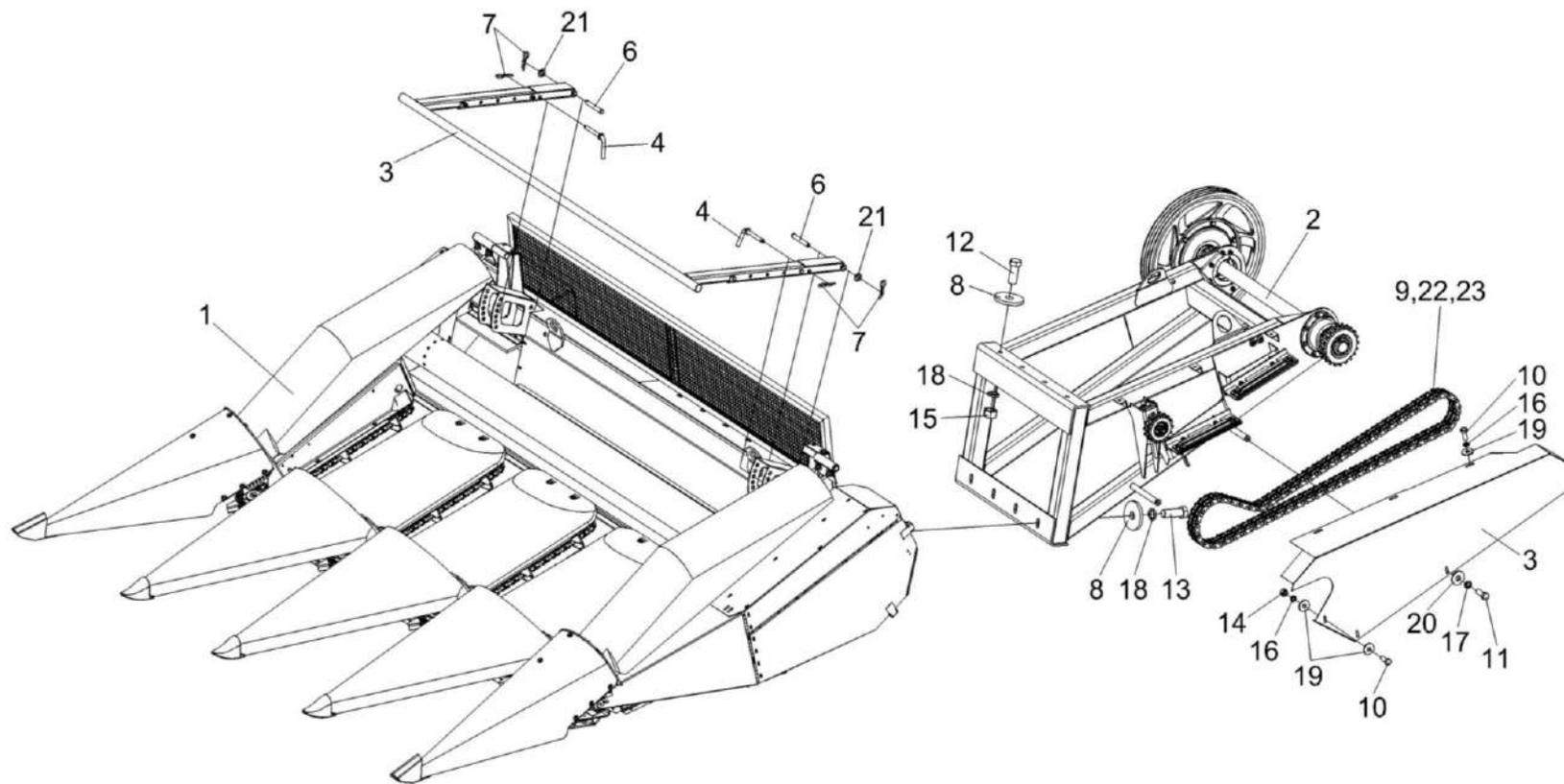
Рисунок 169 – Установка початкоотделителя КП-4-0500000
