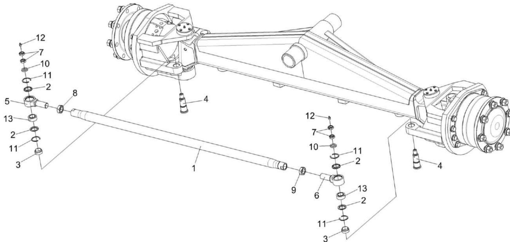
Рисунок 119 – Мост управляемых колес КП-4-0109000. Установка тяги
