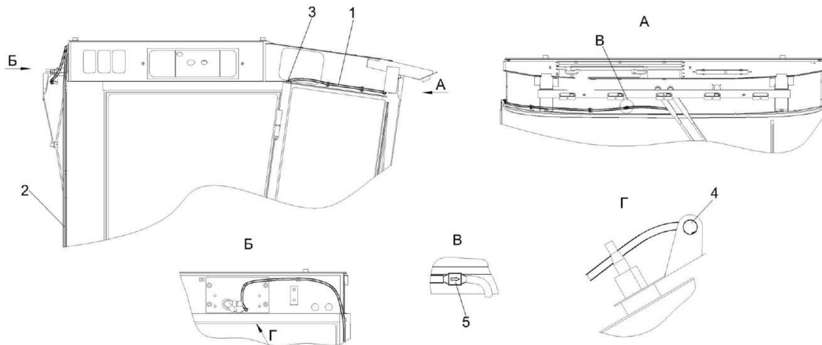
Рисунок 155 – Установка трубопроводов стеклоомывателей КП-4-0120100
