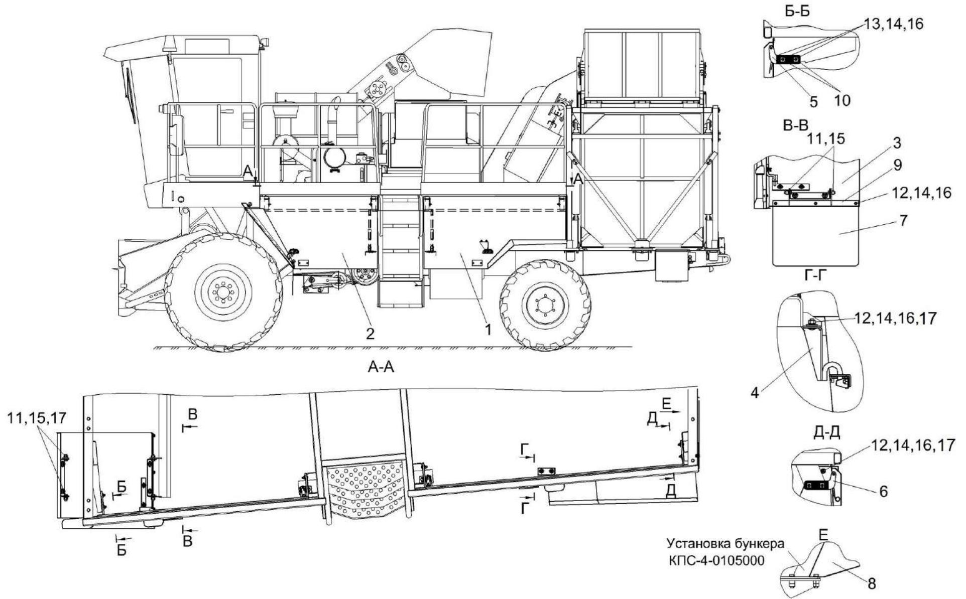
Рисунок 161 – Установка капотов КП-4-0128000 (лист 1)
