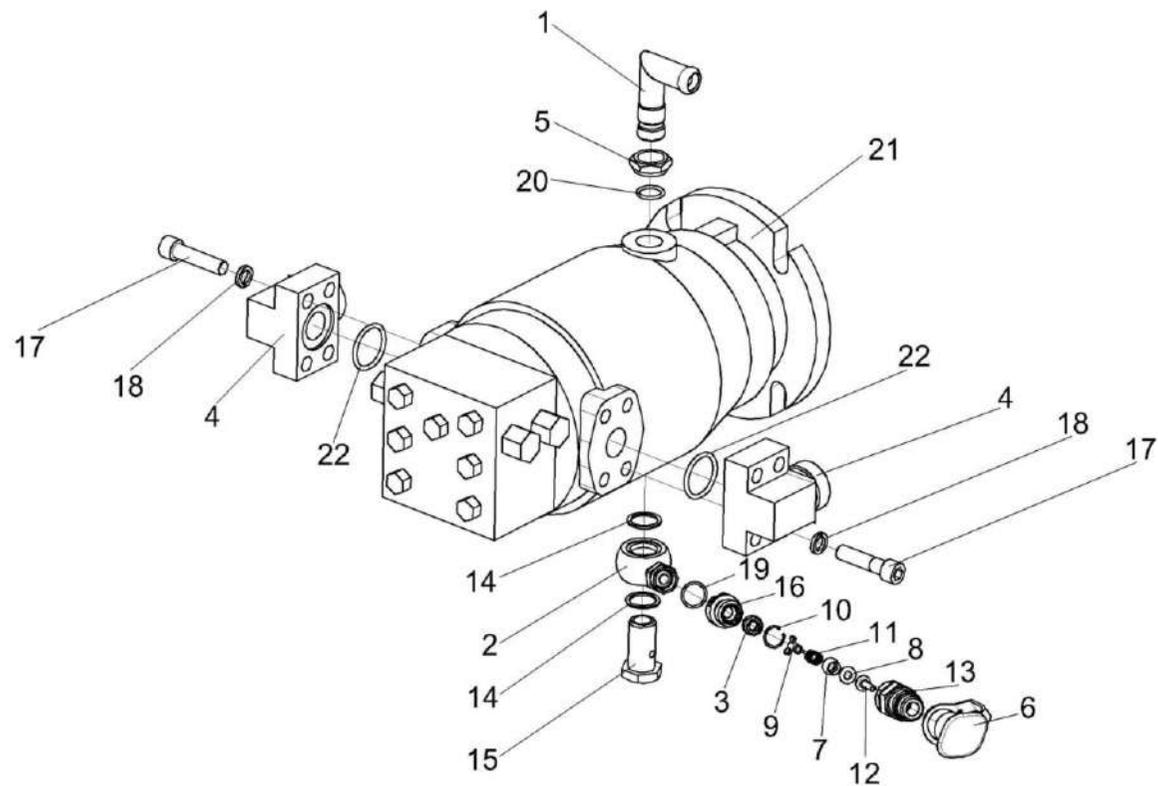
Рисунок 213 – Гидромотор КПС-4-0601230
