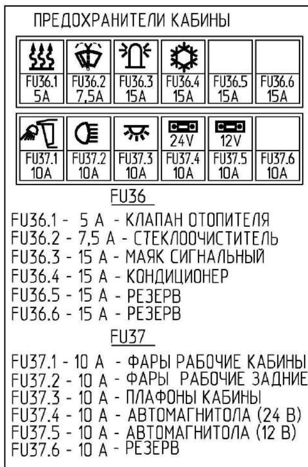
Рисунок 1.13 – Схема соединений предохранителей кабины
