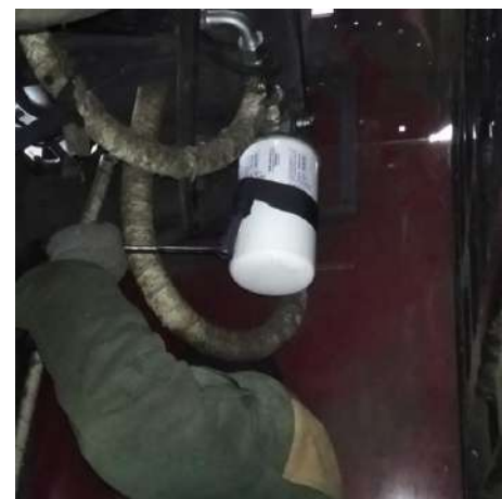
Рисунок 3.9 – Сливной фильтроэлемент, демонтируемый при помощи ключа фильтра
