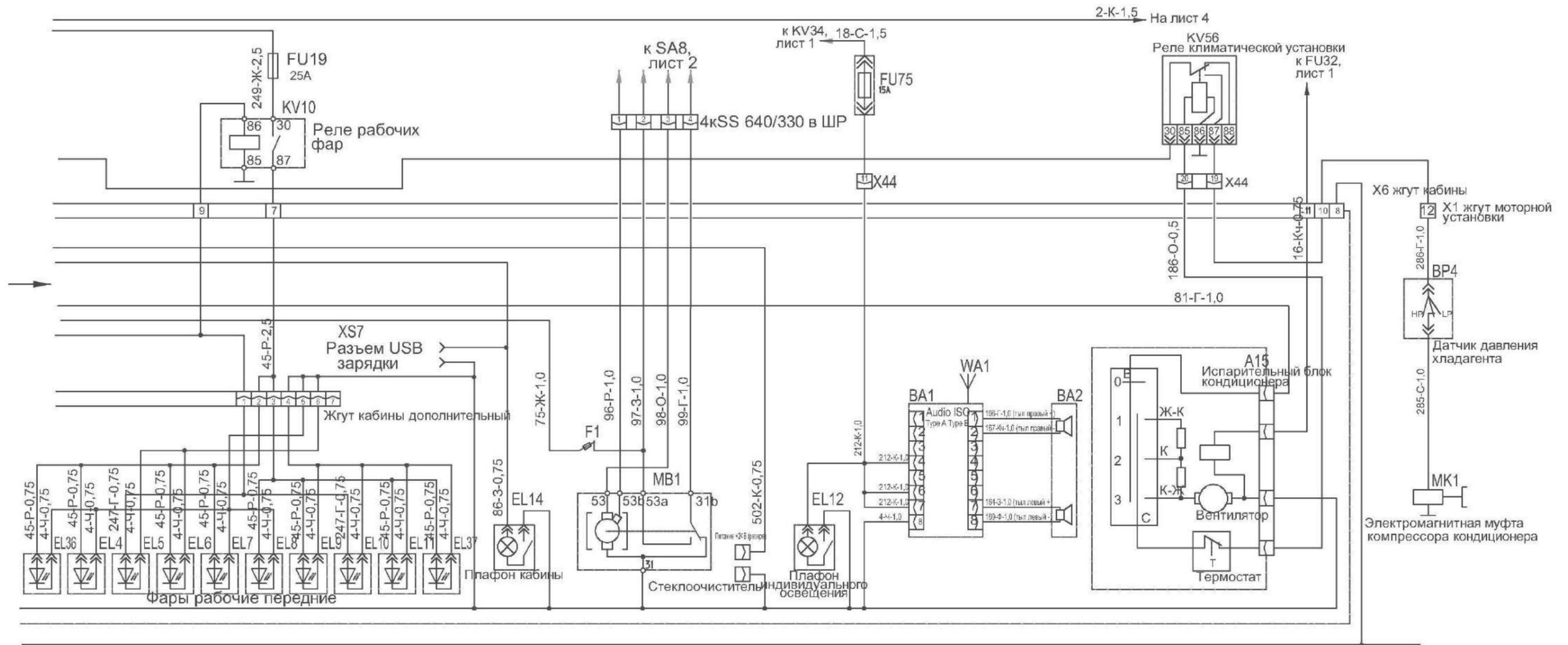
Рисунок Б.3 – Схема электрическая принципиальная комбайна (лист 3)
