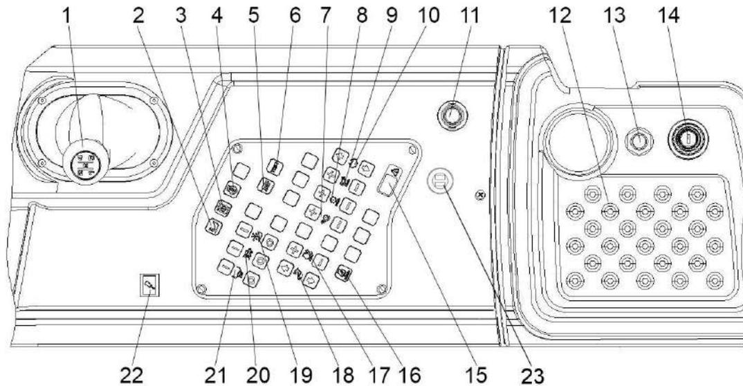
Рисунок 1.31 – Пульт управления комбайна
