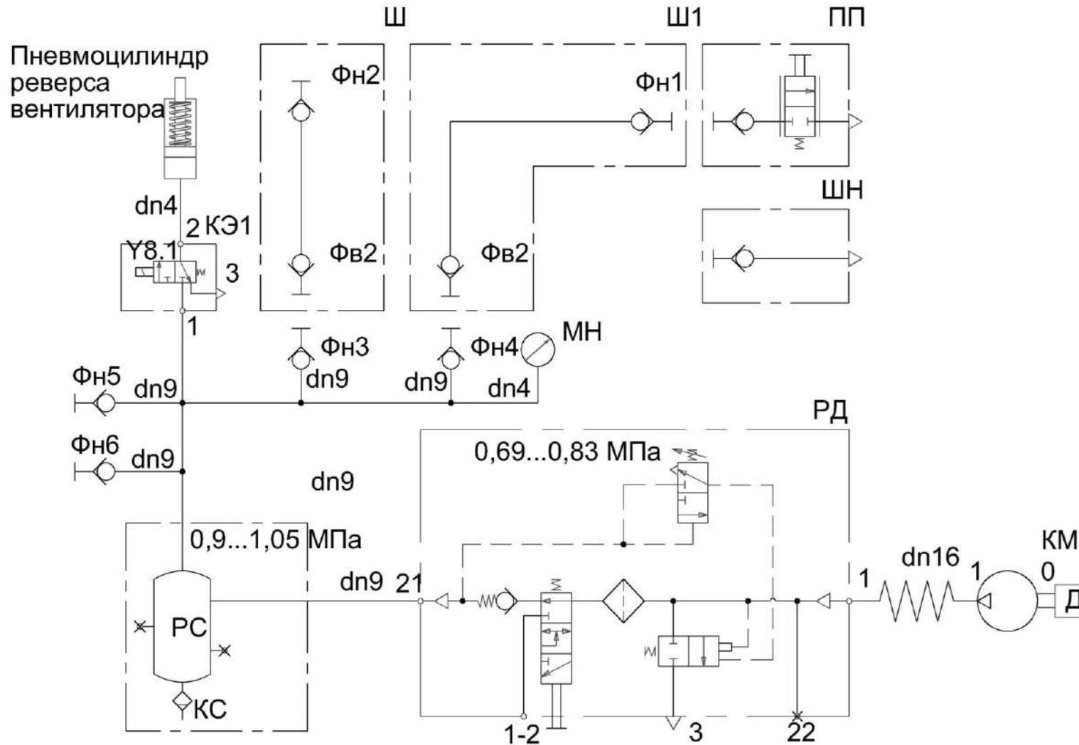
KM - компрессор; КС – клапан слива конденсата; КЭ – клапан электромагнитный; МН – манометр; ПП – пневмопистолет обдувочный; РД – регулятор давления; РС – ресиверы; Фв1, Фв2, Фн1, Фн2, Фн3, Фн4, Фн5, Фн6 - фитинги; Ш, Ш1 – шланги; ШН – шланг для накачивания шин
