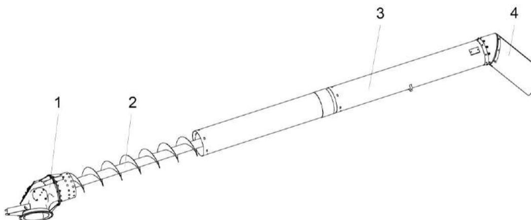
1 – отвод с редуктором; 2 – шнек; 3 – кожух; 4 - фартук
