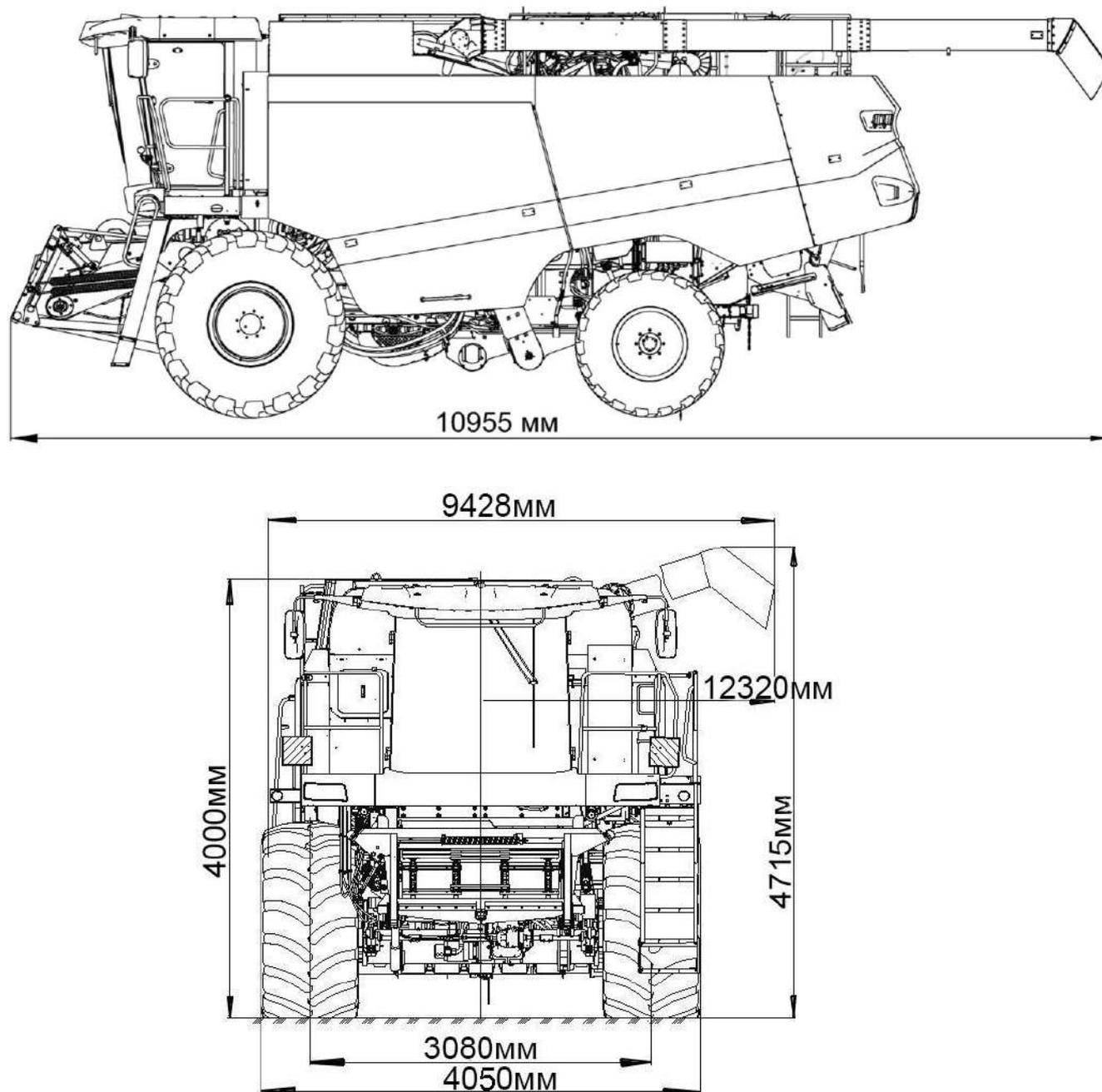
Рисунок 1.1 – Габаритные размеры комбайна
