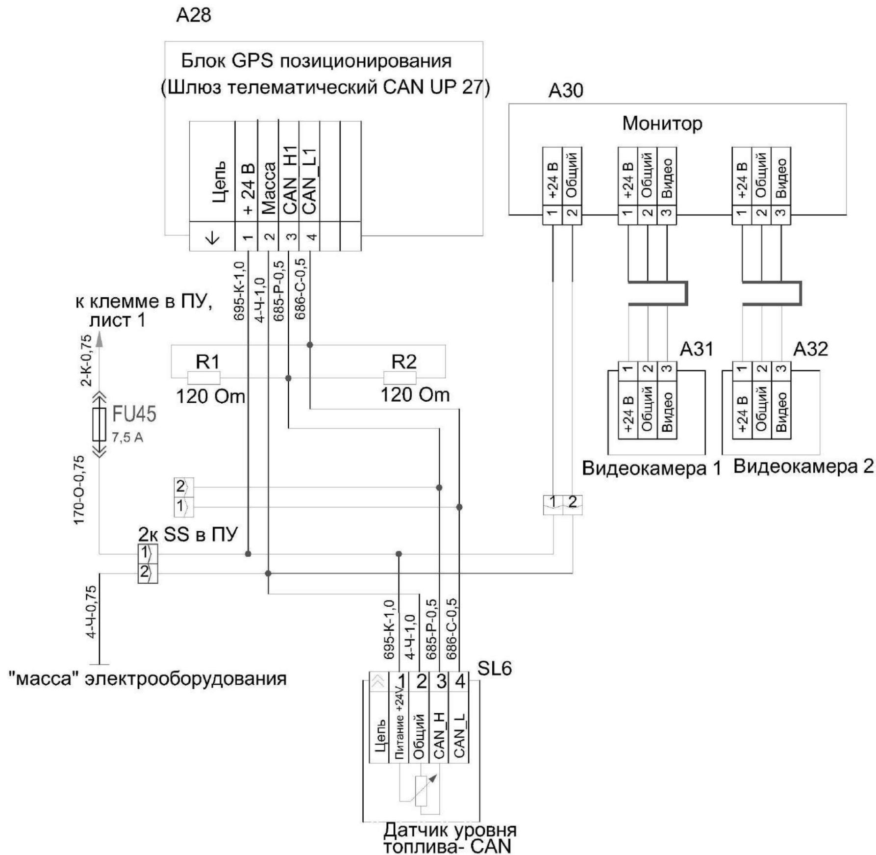
Рисунок Б.8 – Схема электрическая принципиальная комбайна (лист 8)
