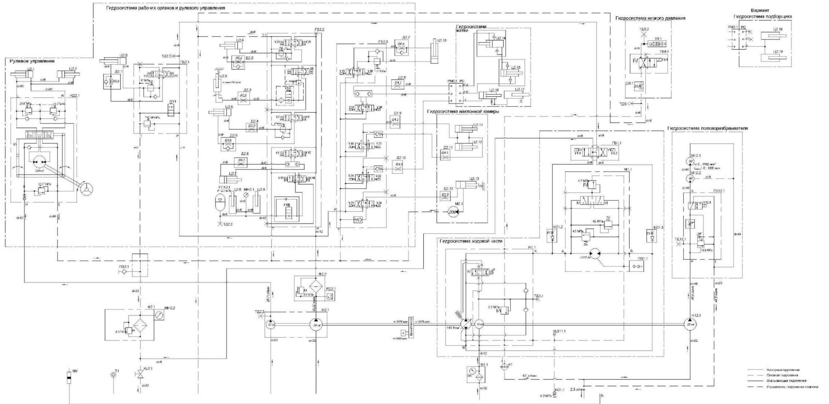
Рисунок А.1 – Схема гидравлическая принципиальная комбайна (лист 1)
