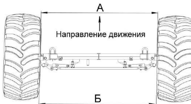
Рисунок 2.27 – Схема регулировки сходимости колес
