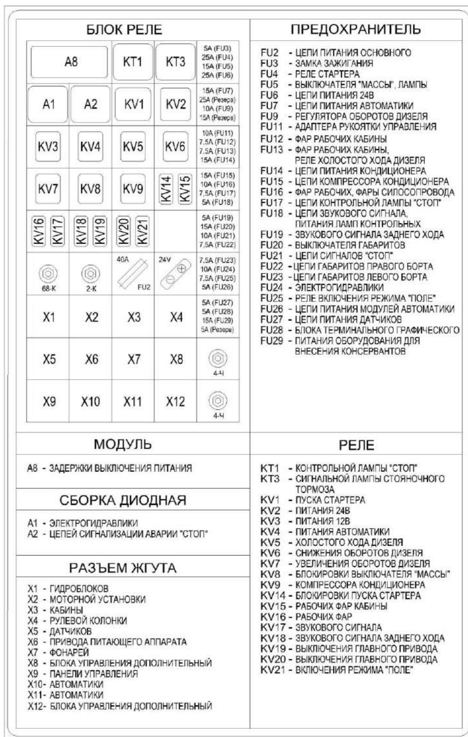
Рисунок 1.23 – Схема соединений шкафа распределительного
