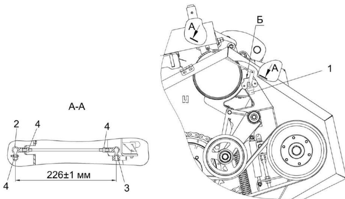
1 – датчик подъема мотовила; 2, 3 - шарниры; 4 - гайки (Мкр от 8 до 10 Н·м)
