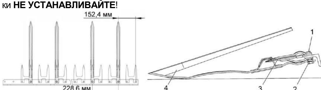
1 – болт крепления стеблеподъемника; 2 – контргайка; 3 – палец режущего аппарата; 4 – стеблеподъемник
