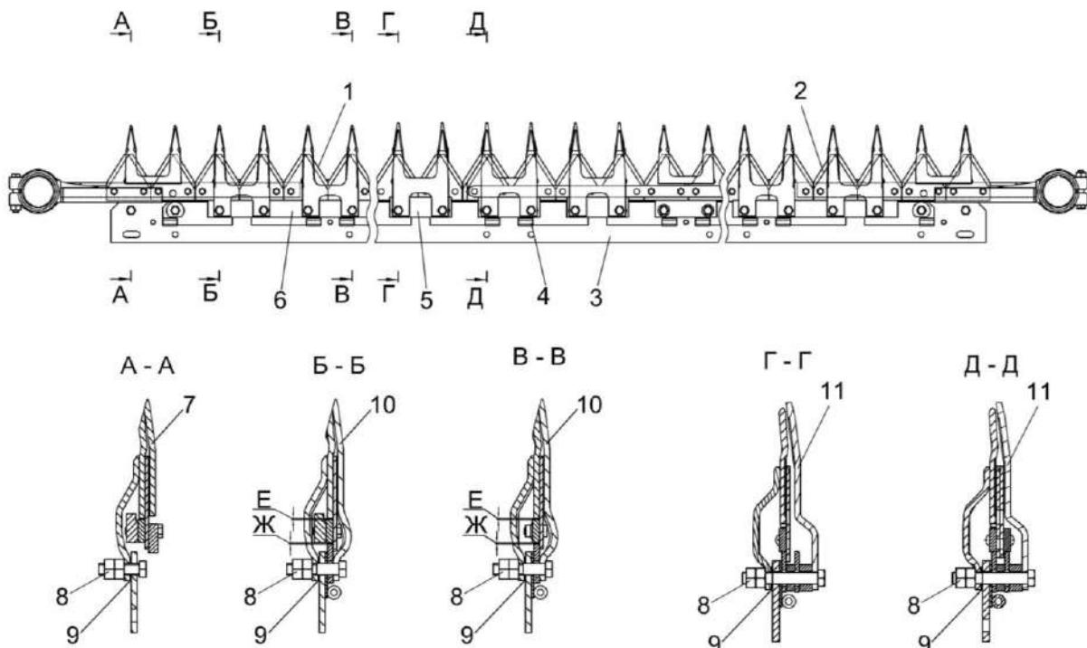
1 – нож левый; 2 – нож правый; 3 – брус пальцевый; 4 – петля; 5, 6 – пластины трения; 7 - палец направленный сдвоенный; 8 – гайки; 9 – прокладка; 10 - палец сдвоенный; 11 – палец
