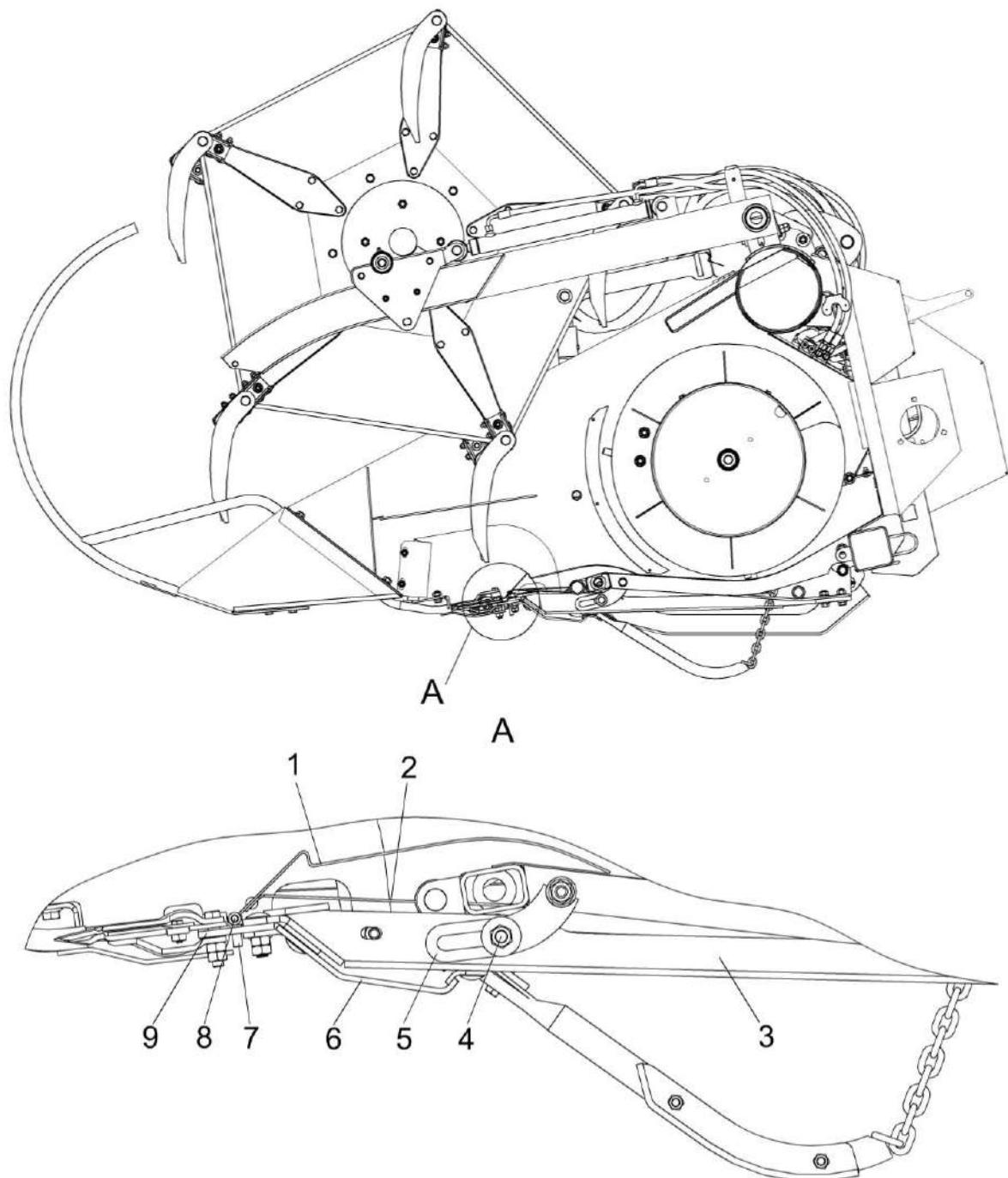
1 - щиток; 2 – рессора; 3 - рычаг; 4 – гайка; 5 – ограничитель хода; 6 - полозья; 7 – винт;
