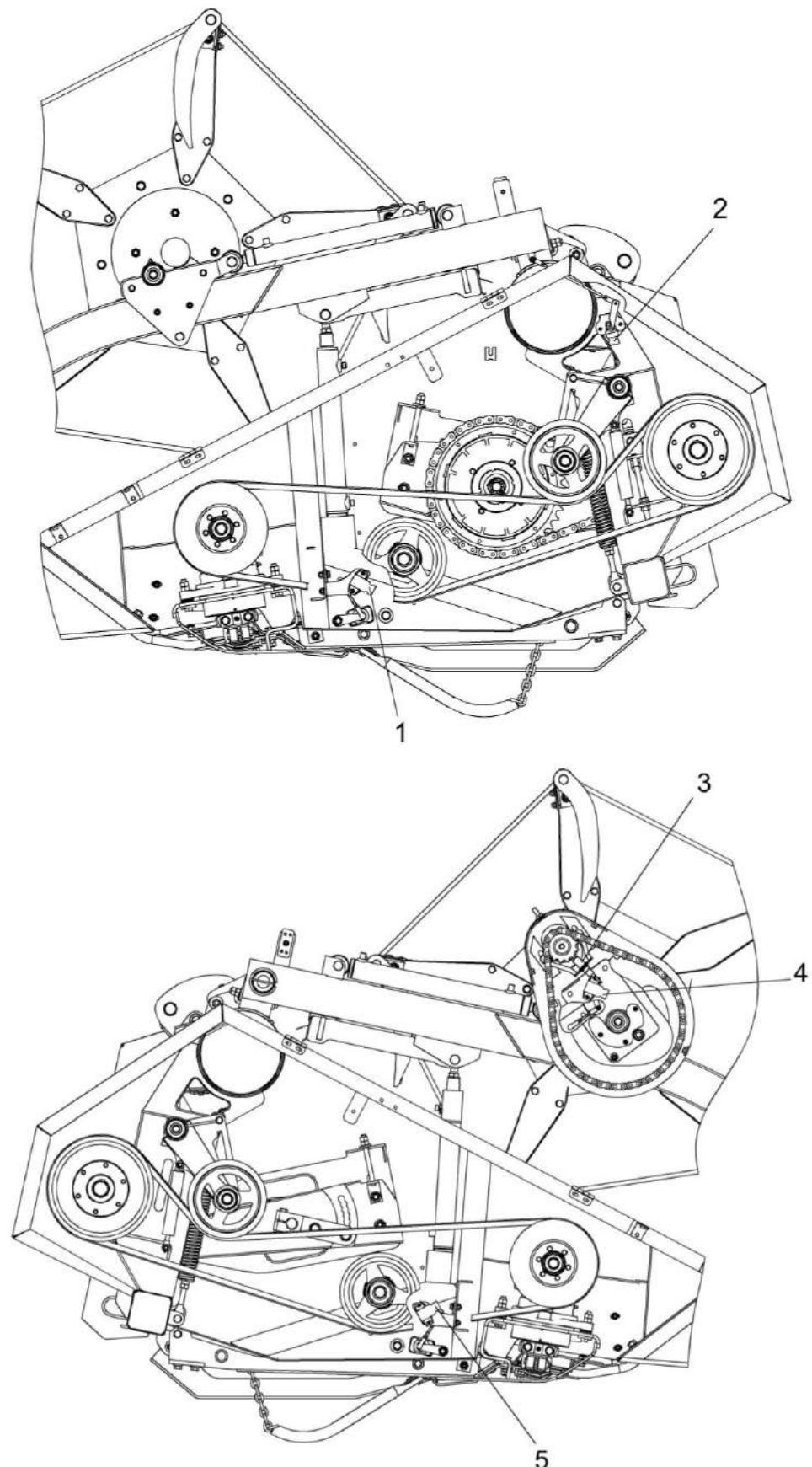
1, 5 - датчик положения копиров; 2 - датчик подъема мотовила; 3 - датчик оборотов мотовила; 4 - датчик выдвижения мотовила
