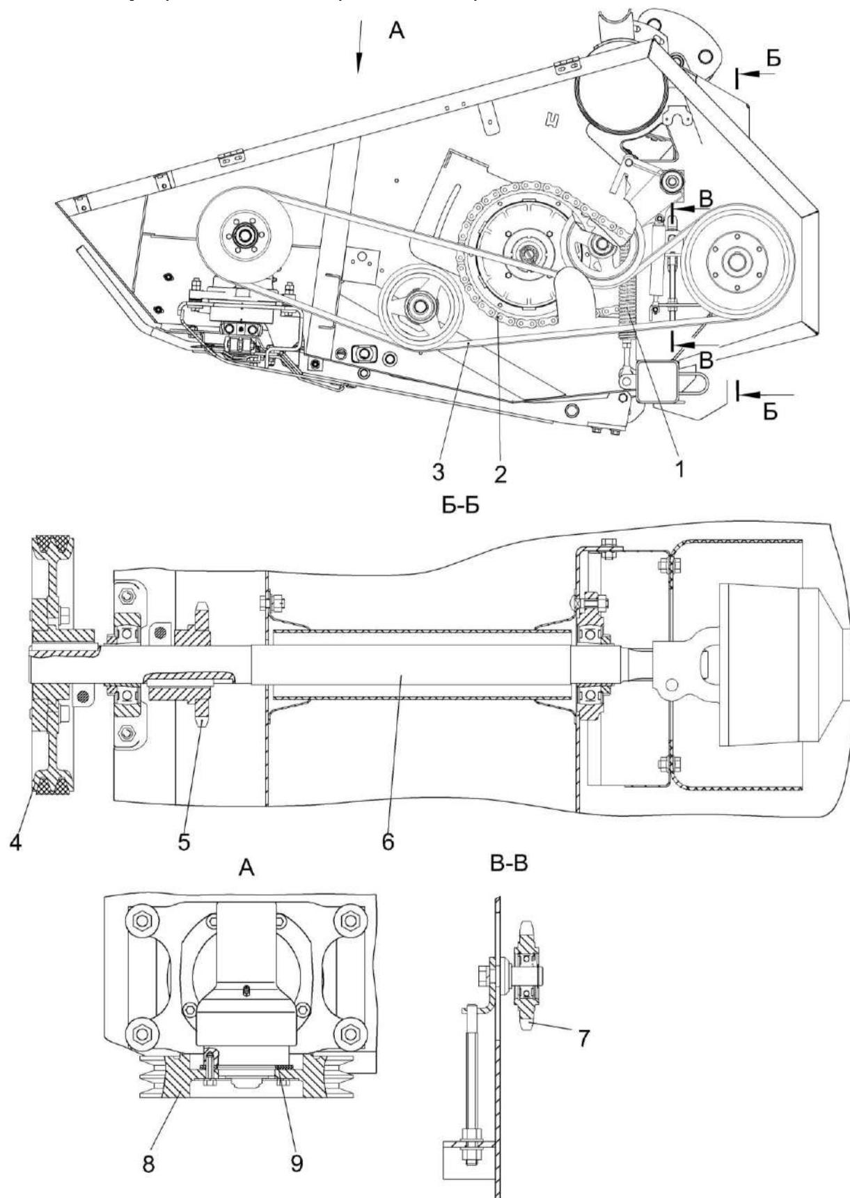
1 - пружина; 2 – цепная передача; 3 - ременная передача; 4, 8 - звездочки; 5, 7 - шкивы;
