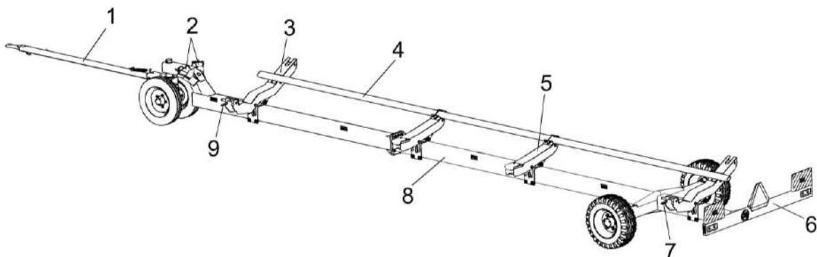
1 – дышло; 2 - упоры противооткатные; 3, 5 - ложементы; 4 – упоры; 6 – балка габаритная;
