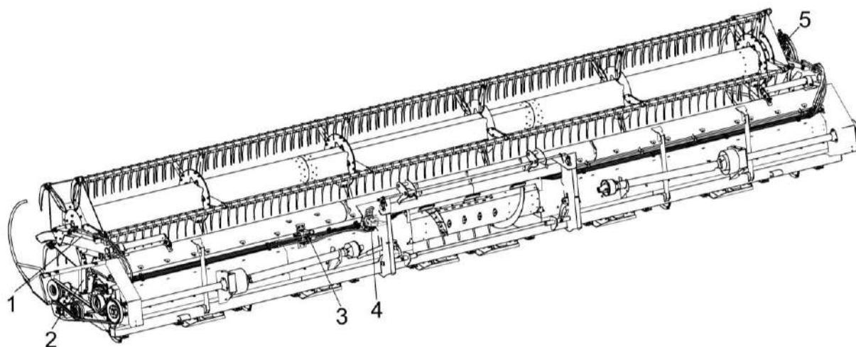
1 – гидроцилиндр горизонтального перемещения мотовила; 2 - гидроцилиндр вертикального перемещения мотовила; 3 - гидроблок; 4 - разъем гидравлический; 5 - гидромотор
