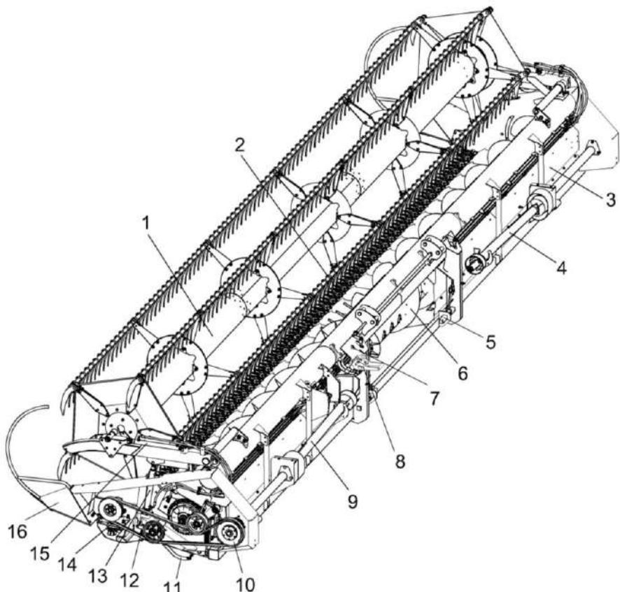
1 – мотовило; 2 – режущий аппарат; 3 – рама; 4, 9 - валы карданные; 5 - механизм фиксации; 6 – шнек; 7 - разъем электрический жатки; 8 - гидросистема жатки; 10 - привод жатки; 11 - копиры; 12 - установка датчиков; 13 - гидроцилиндры подъема мотовила; 14 - редуктор; 15 – гидроцилиндры выноса мотовила; 16 – делители
