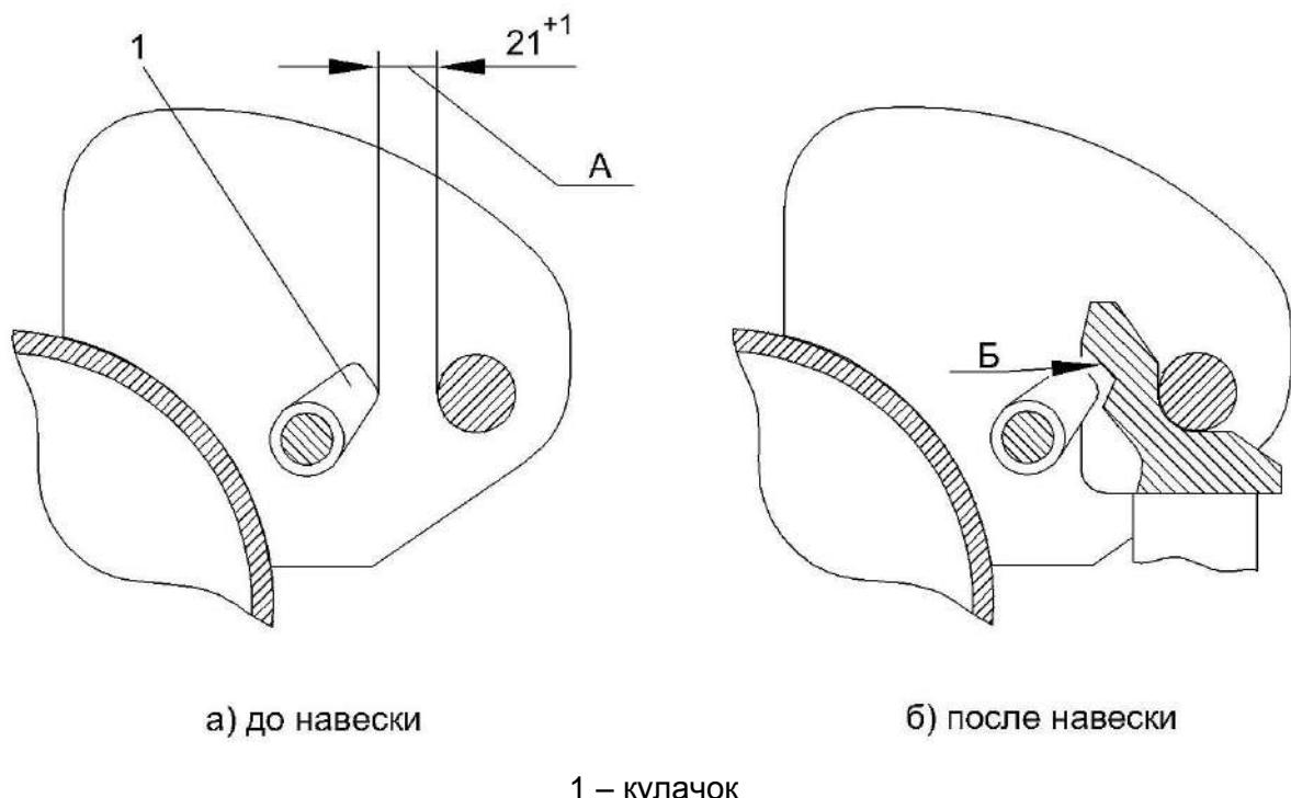
Рисунок 2.3 – Перекрытие кулачка и упора гидроцилиндра в зафиксированном верхнем ловителе жатки
