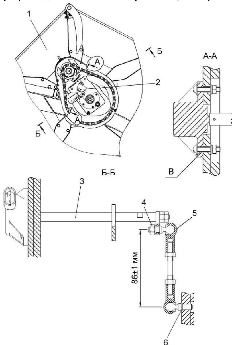
1- мотовило; 2 – датчик выдвижения мотовила; 3 - ось; 4 - гайка; 5, 6 - шарниры
