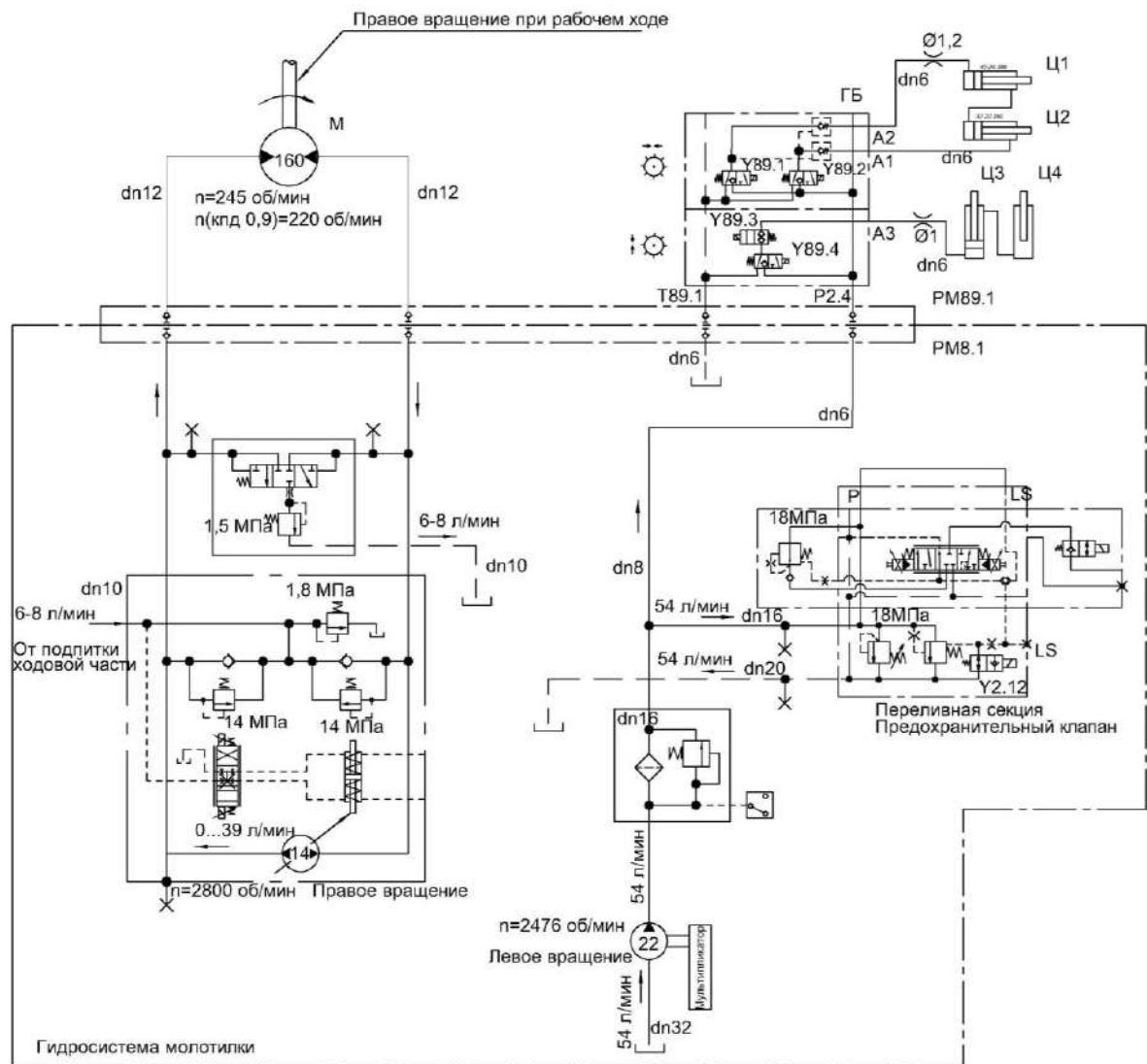
Ц1, Ц2 - гидроцилиндры горизонтального перемещения мотовила; Ц3, Ц4 - гидроцилиндры вертикального перемещения мотовила; М - гидромотор привода мотовила; ГБ – гидроблок; PM8.1 – разъем мобильный; PM89.1 – разъем стационарный
