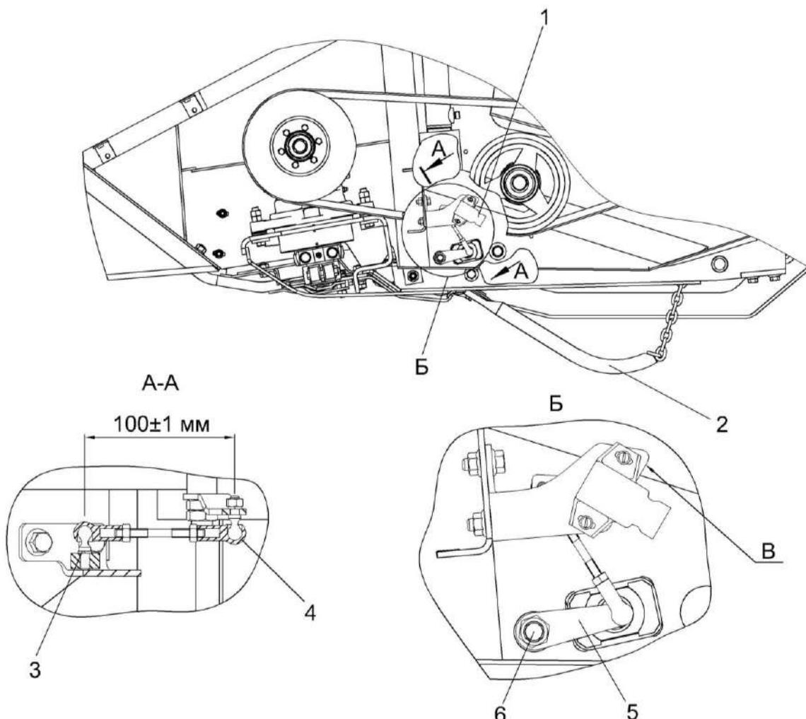
1- датчик положения копиров; 2 – копир; 3, 4 – шарниры; 5 - рычаг; 6 - гайка
