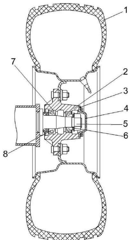
1 -колесо; 2 – ступица; 3 –прокладка; 4 - крышка; 5 - гайка; 6 - шайба стопорная; 7, 8 - подшипники
