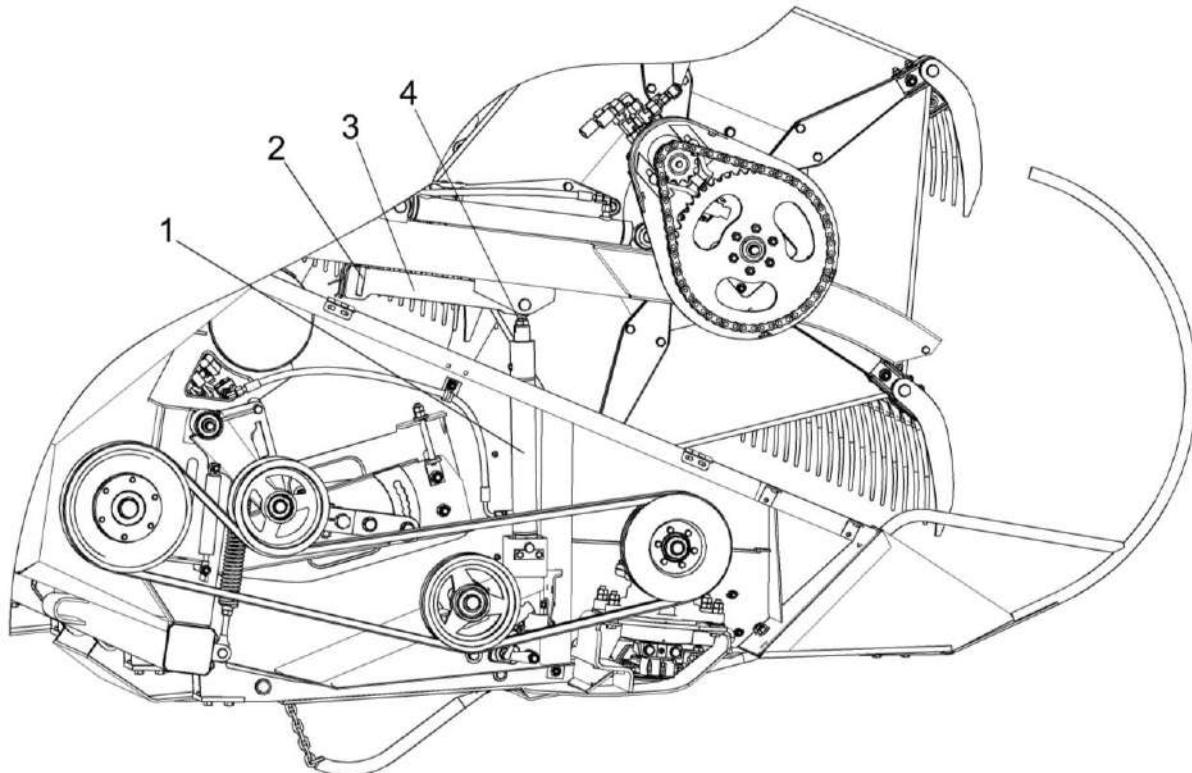
1 – гидроцилиндр подъема мотовила; 2 – фиксатор; 3 – упор; 4 - гайка
