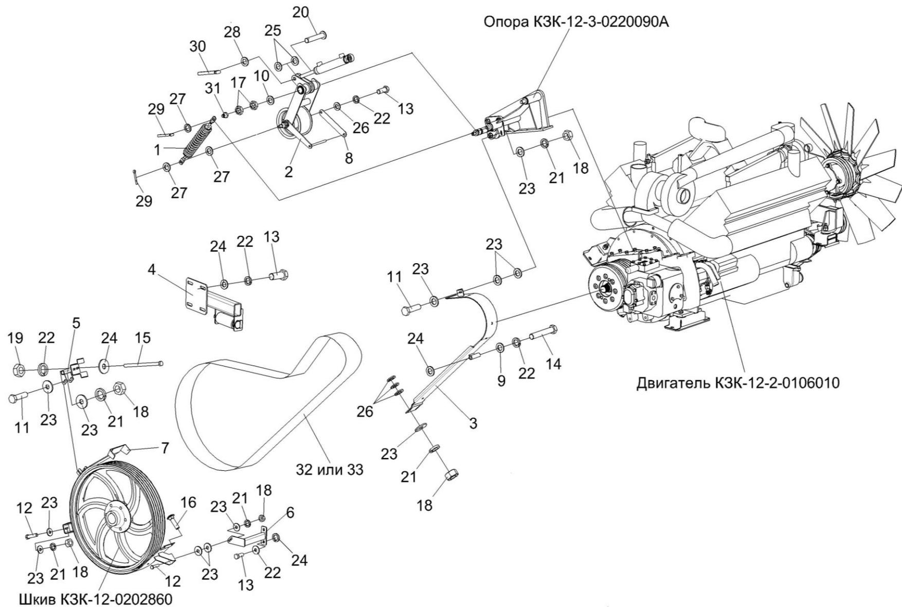
Рисунок 209 – Привод главного контрпривода КЗК-12-3-0220000
