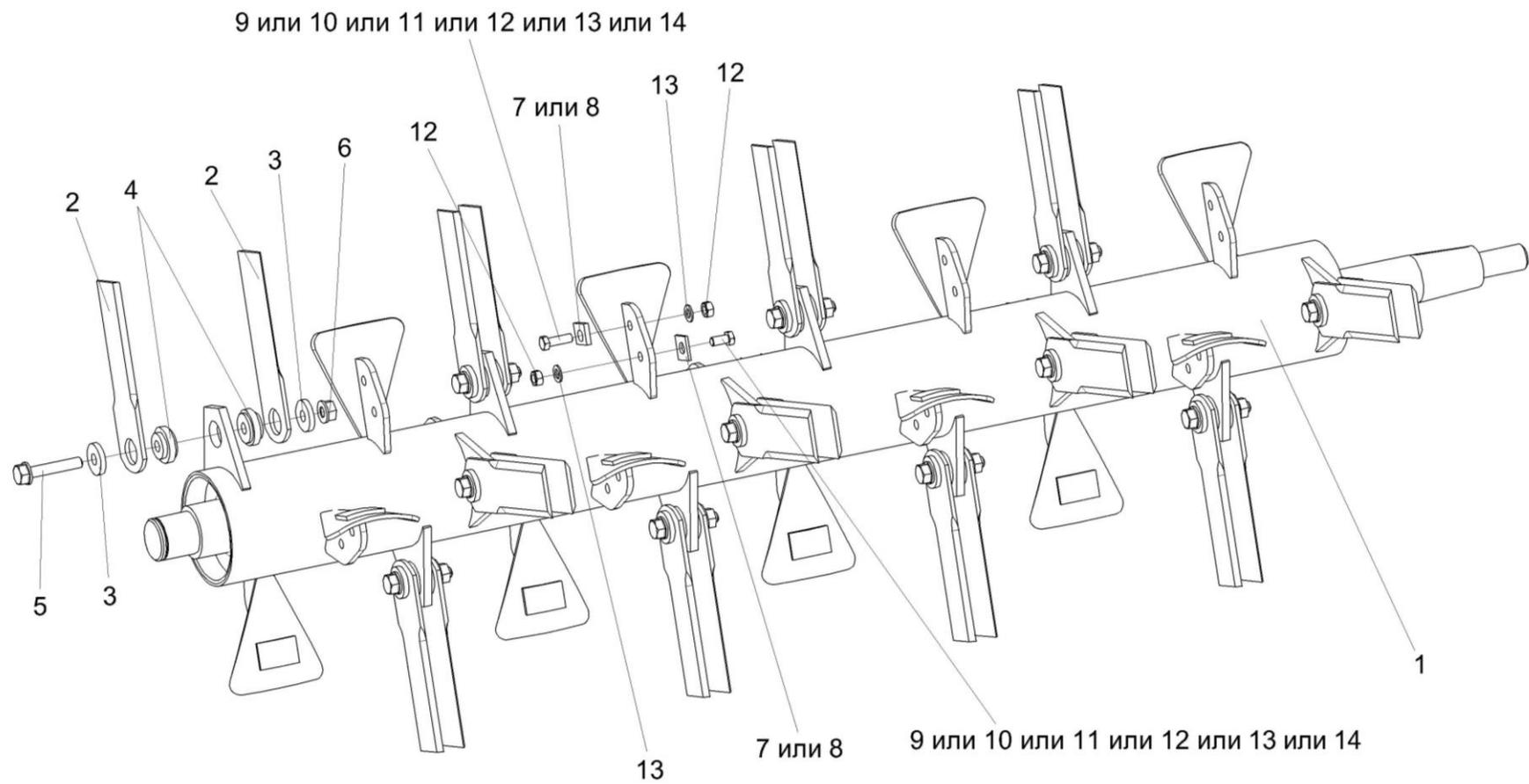
Рисунок 126 – Ротор измельчителя КЗК-10-0290140
