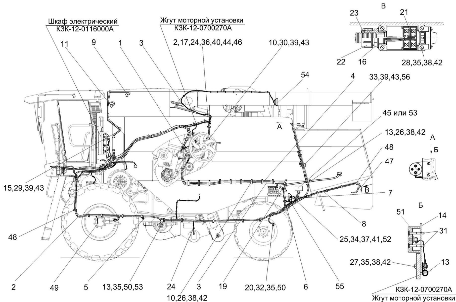
Рисунок 6 – Электрооборудование молотилки самоходной КЗК-12-010000Б-10 (лист 1)
