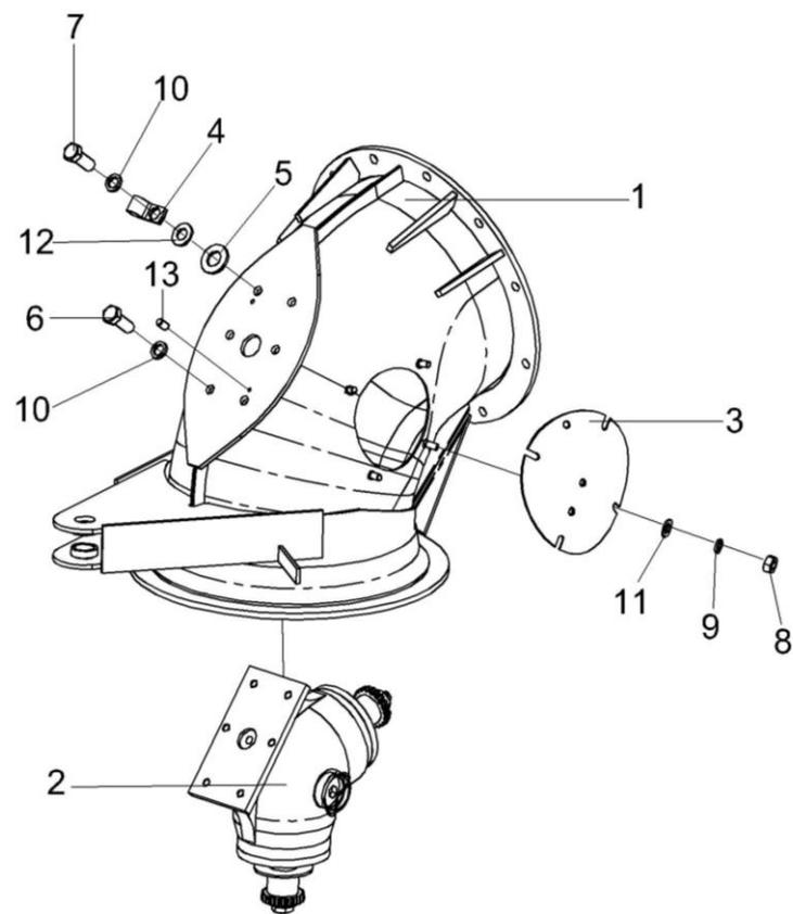
Рисунок 109 – Отвод с редуктором КЗК-12-0206230А
