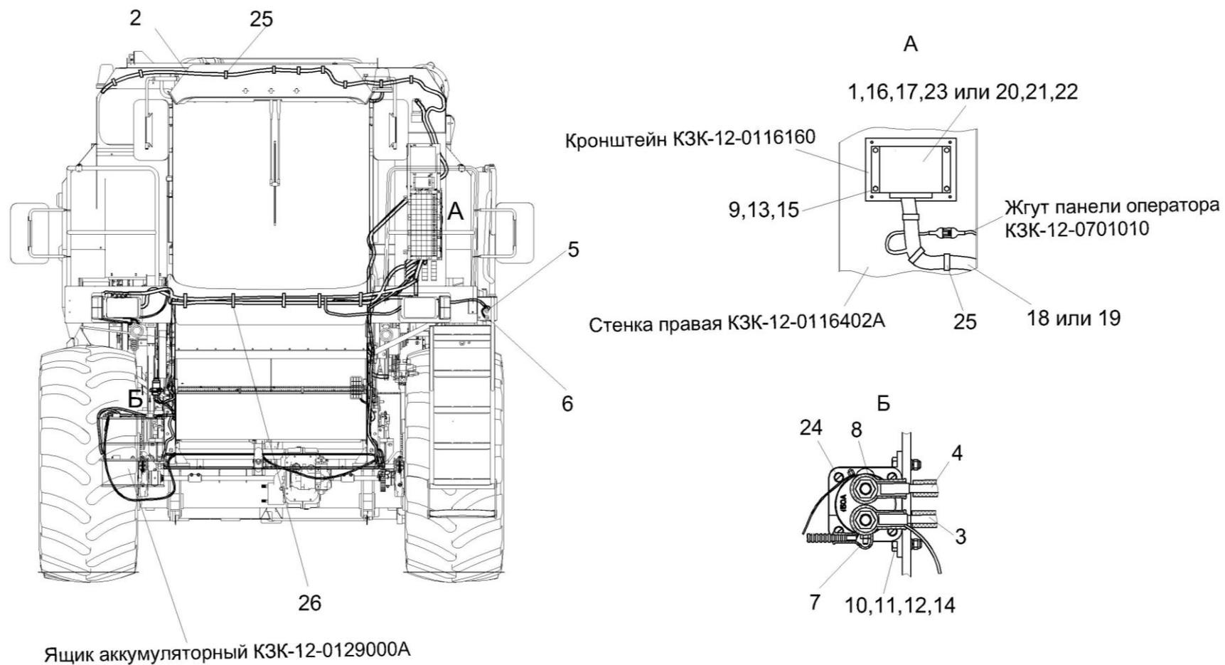
Рисунок 9 – Электрооборудование молотилки самоходной КЗК-12-0100000Б-10 (лист 4)
