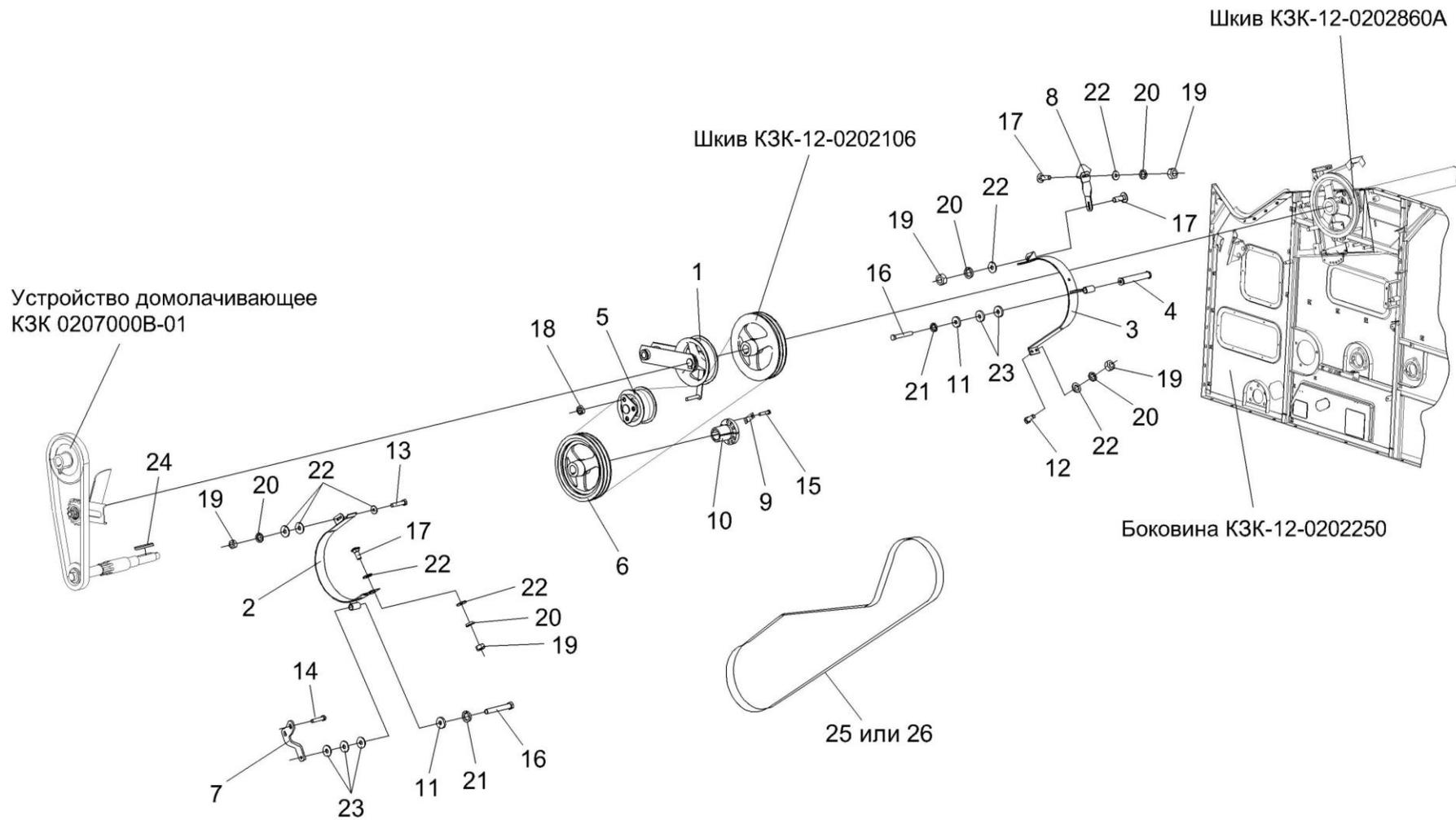
Рисунок 119 – Привод выгрузки КЗК-12-0221100А (лист 2)
