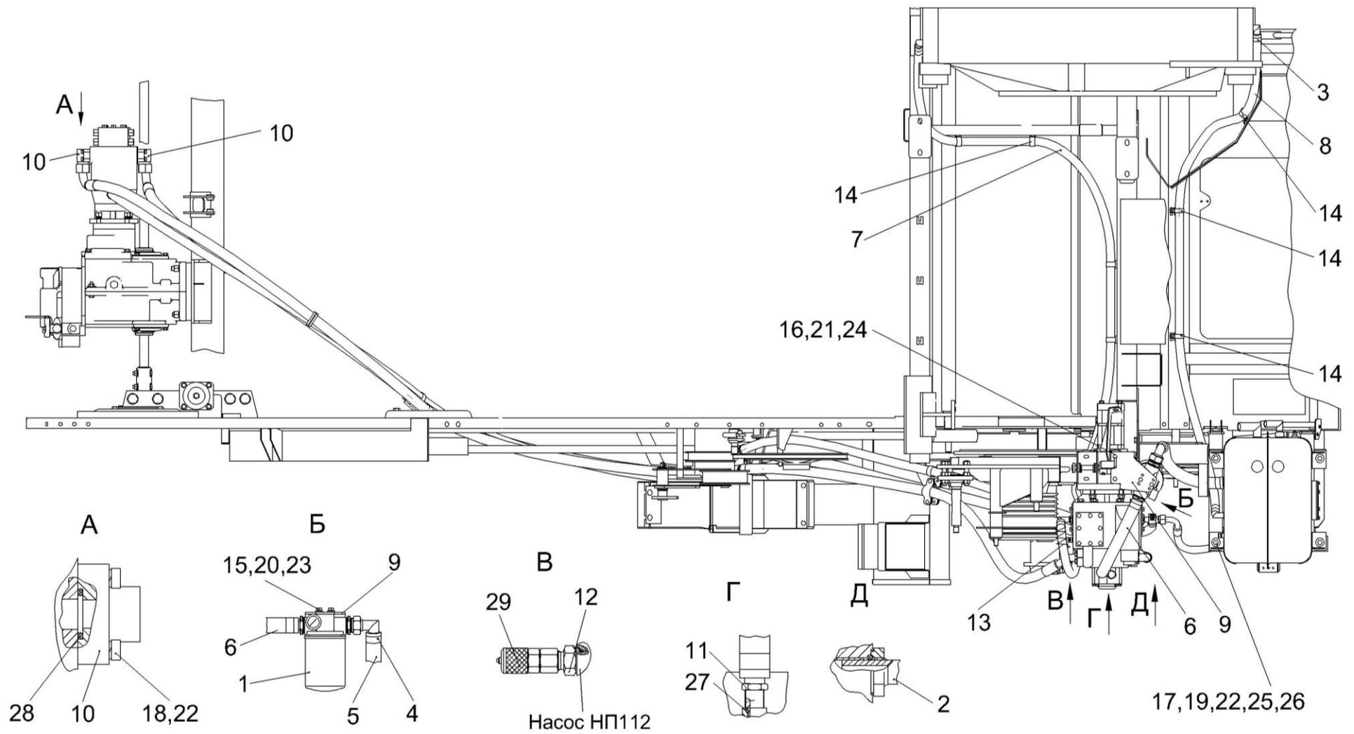
Рисунок 214 – Гидросистема привода ходовой части КЗК-12-0601000Б (вид сверху)
