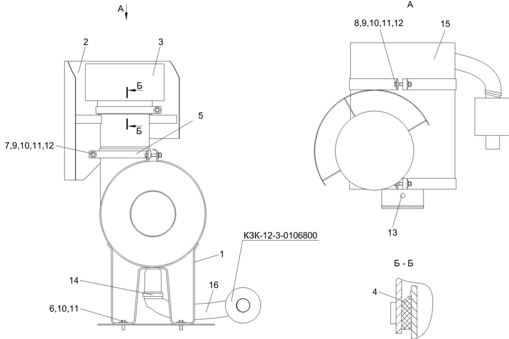
Рисунок 243 – Установка воздухоочистителя G150092 КЗК-12-3-0106760
