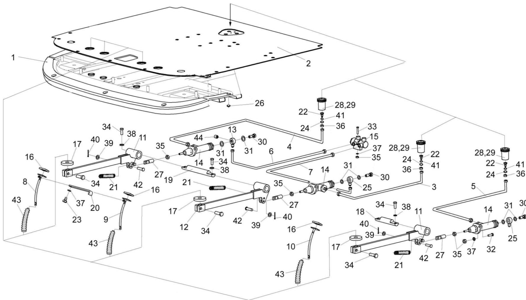
Рисунок 142 – Рычаги и трубопроводы площадки управления
