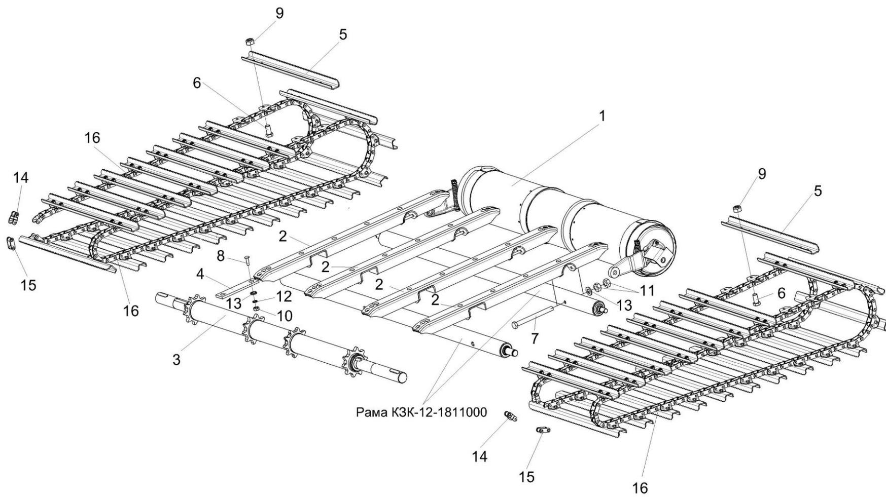
Рисунок 12 – Установка транспортера КЗК 1877400
