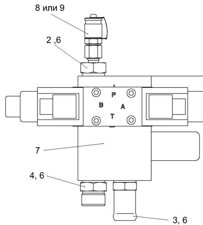
Рисунок 234 – Гидроблок односекционный КЗК-12-0602670
