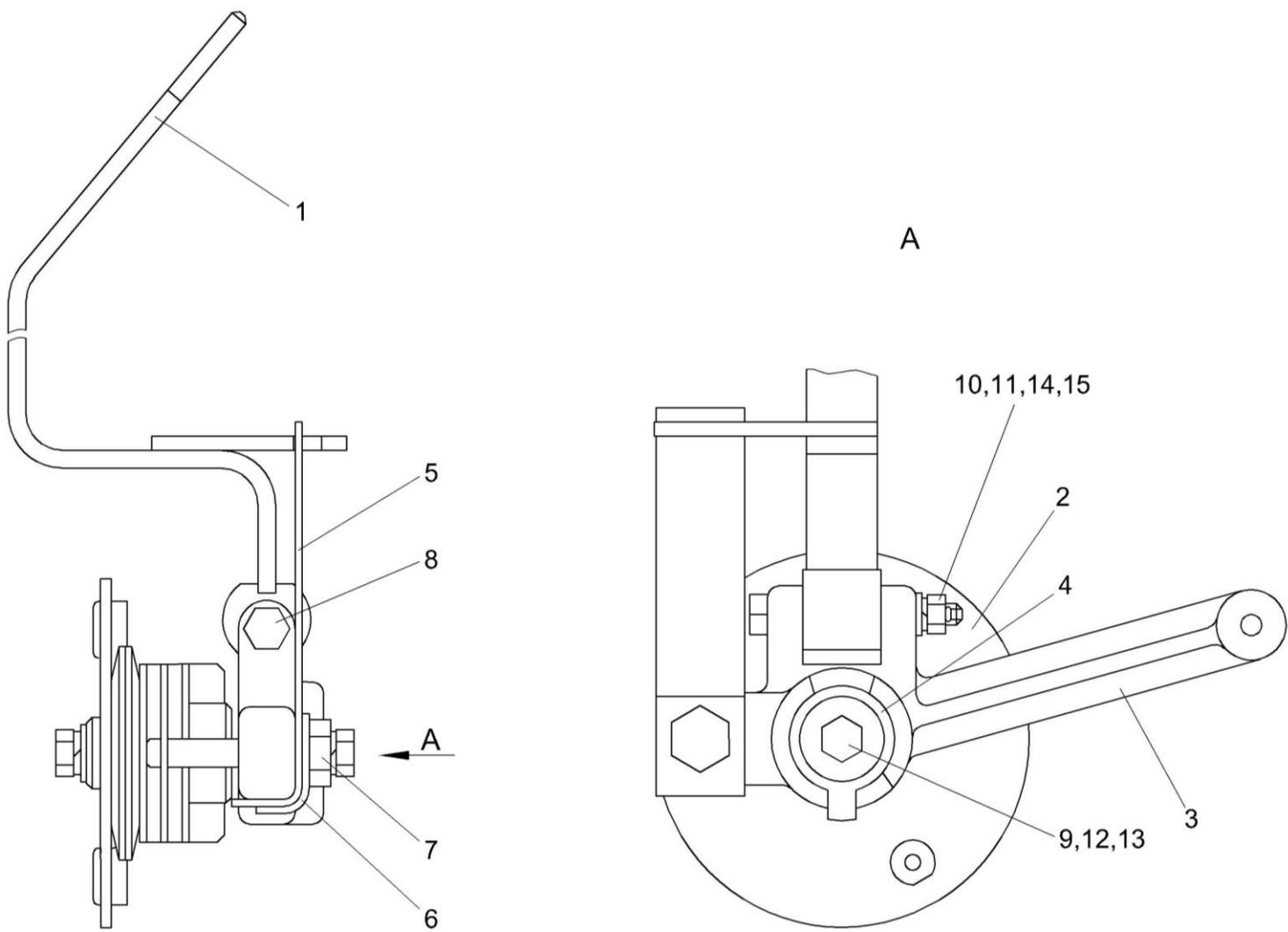
Рисунок 149 – Рычаг КЗК-12-0119440А
