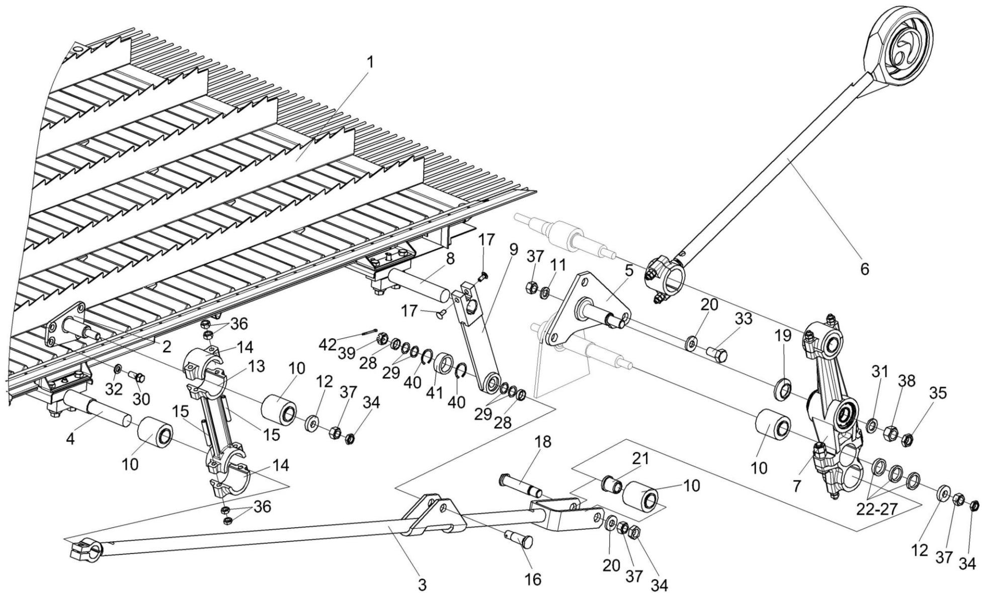
Рисунок 41 – Установка привода доски стрясной КЗК-12-0280000А (вид слева)
