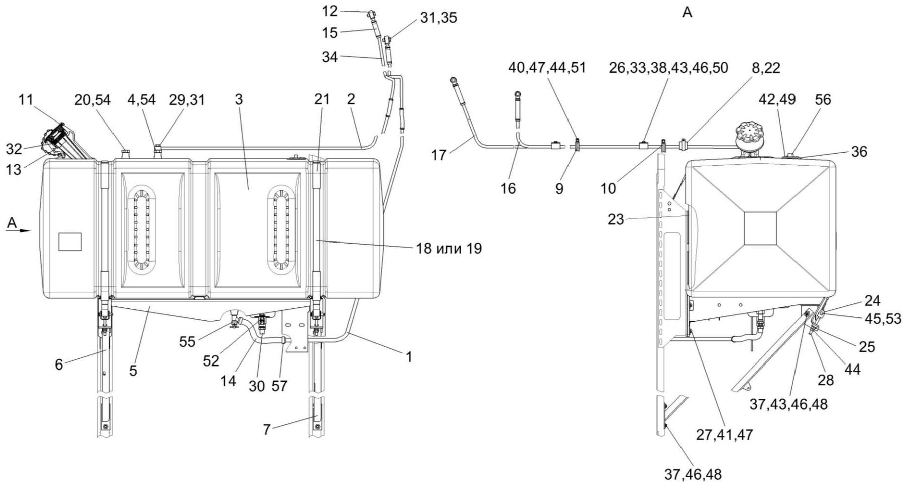
Рисунок 178 – Установка бака топливного КЗК-12-2-0126000
