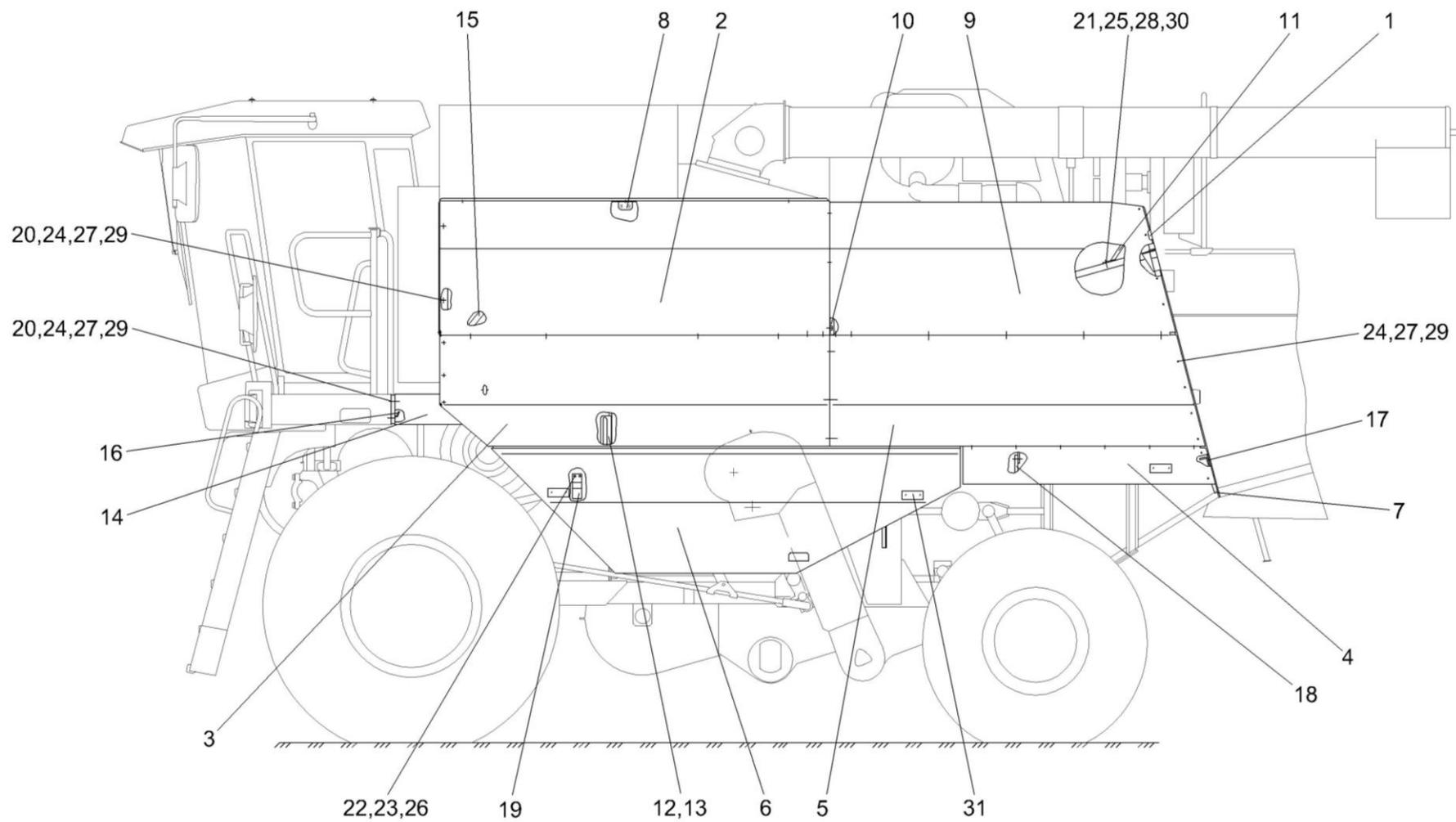
Рисунок 168 – Установка капотов и ограждения КЗК-12-0128000А (вид слева)
