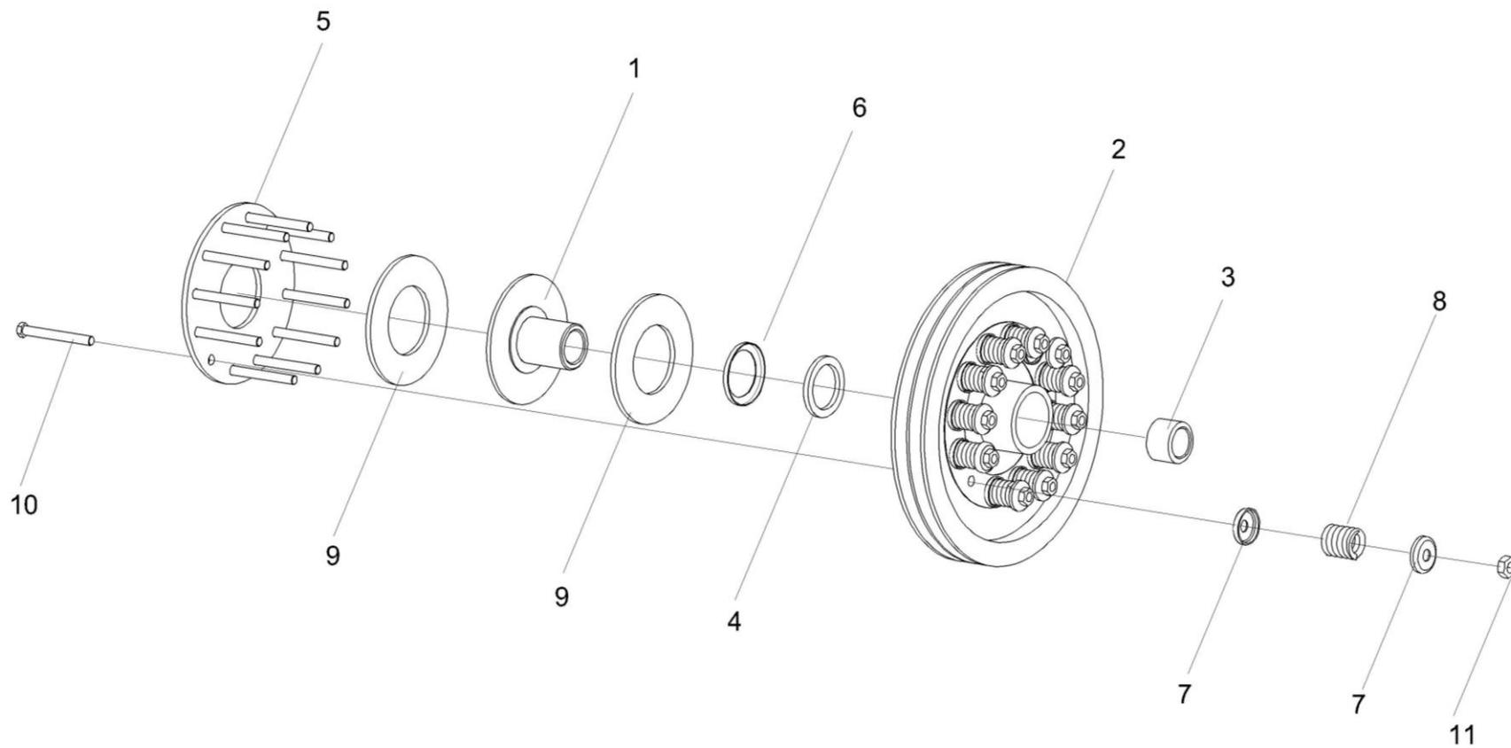
Рисунок 115 – Муфта фрикционная КЗК-10-0219100
