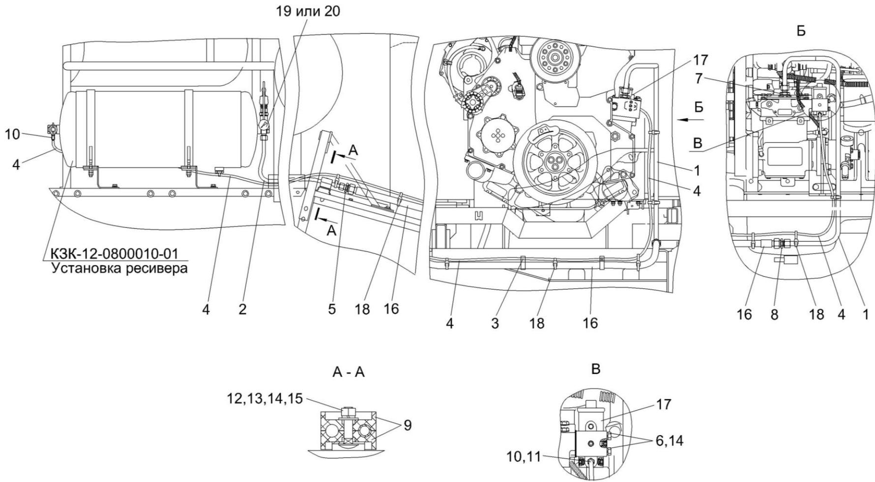
Рисунок 239 – Пневмосистема КЗК-12-2-0800000
