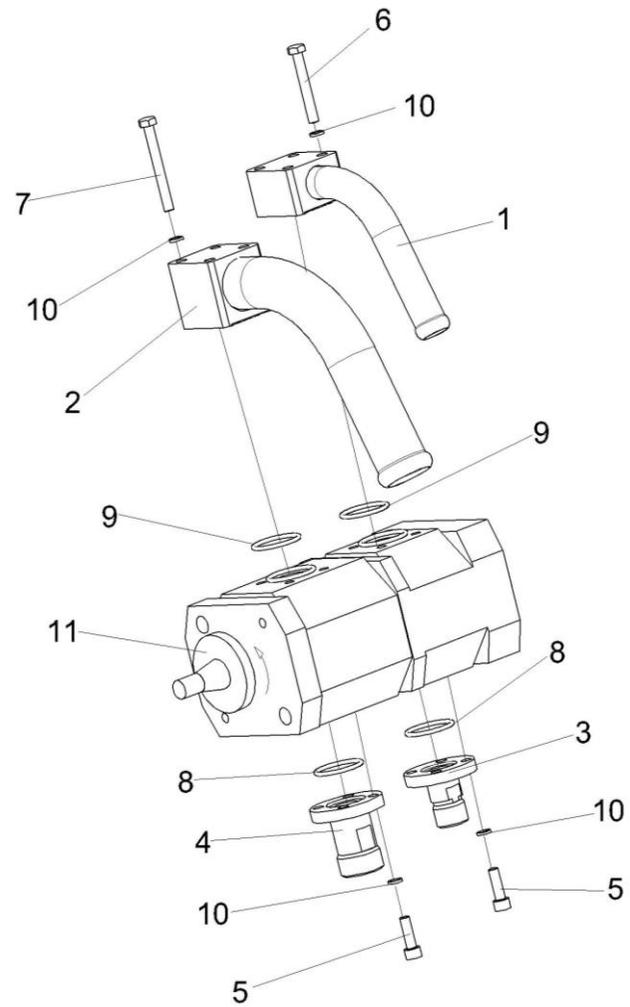
Рисунок 186 – Гидронасос двухсекционный КЗК-12-0602910А
