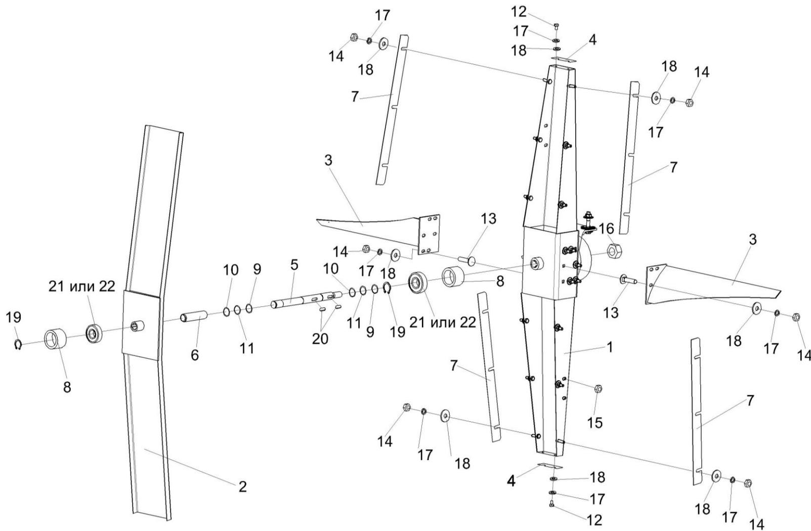
Рисунок 199 – Пылесъемник КЗК-12-3-0112130А
