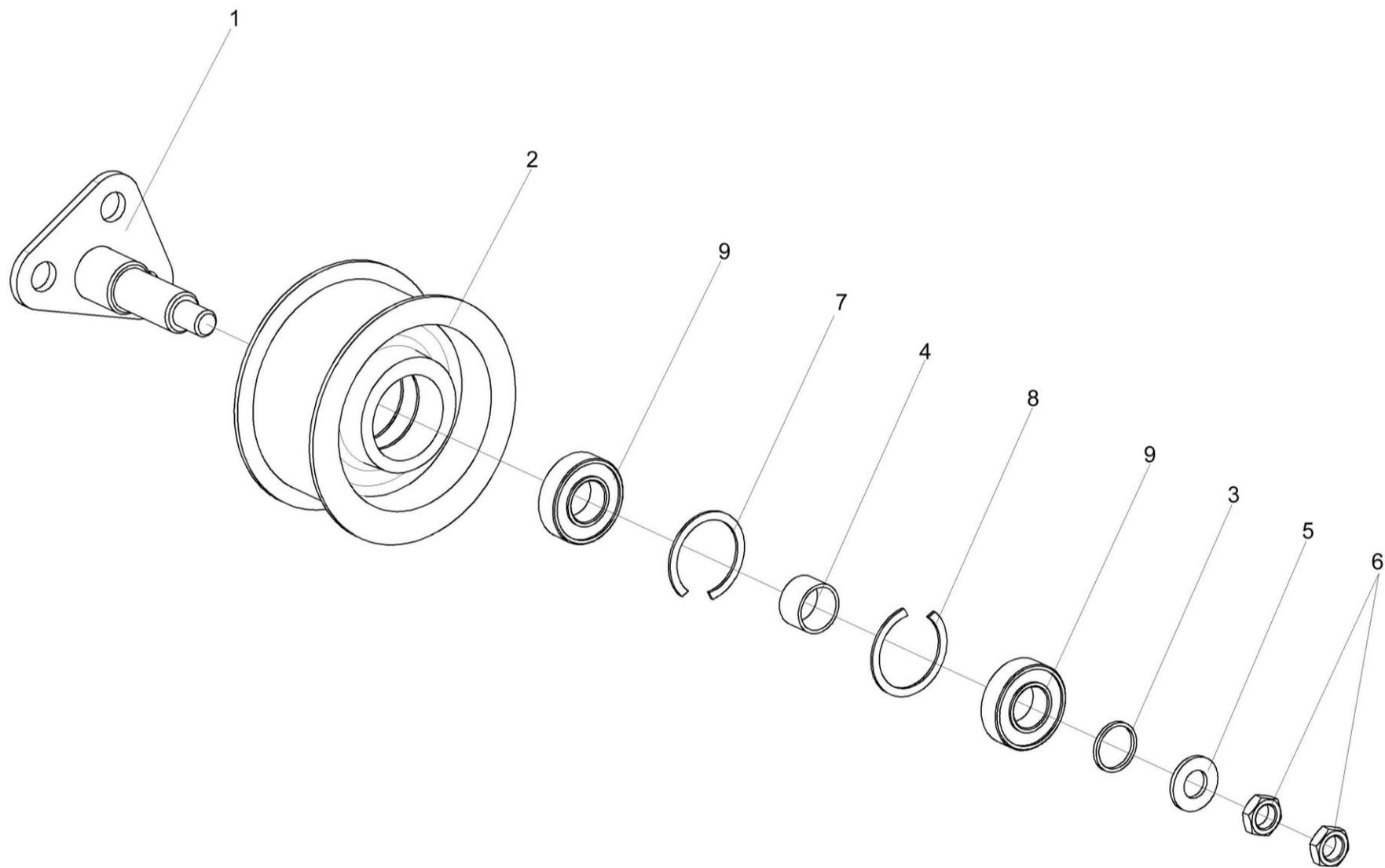
Рисунок 31 – Ролик КЗК-12-0125090
