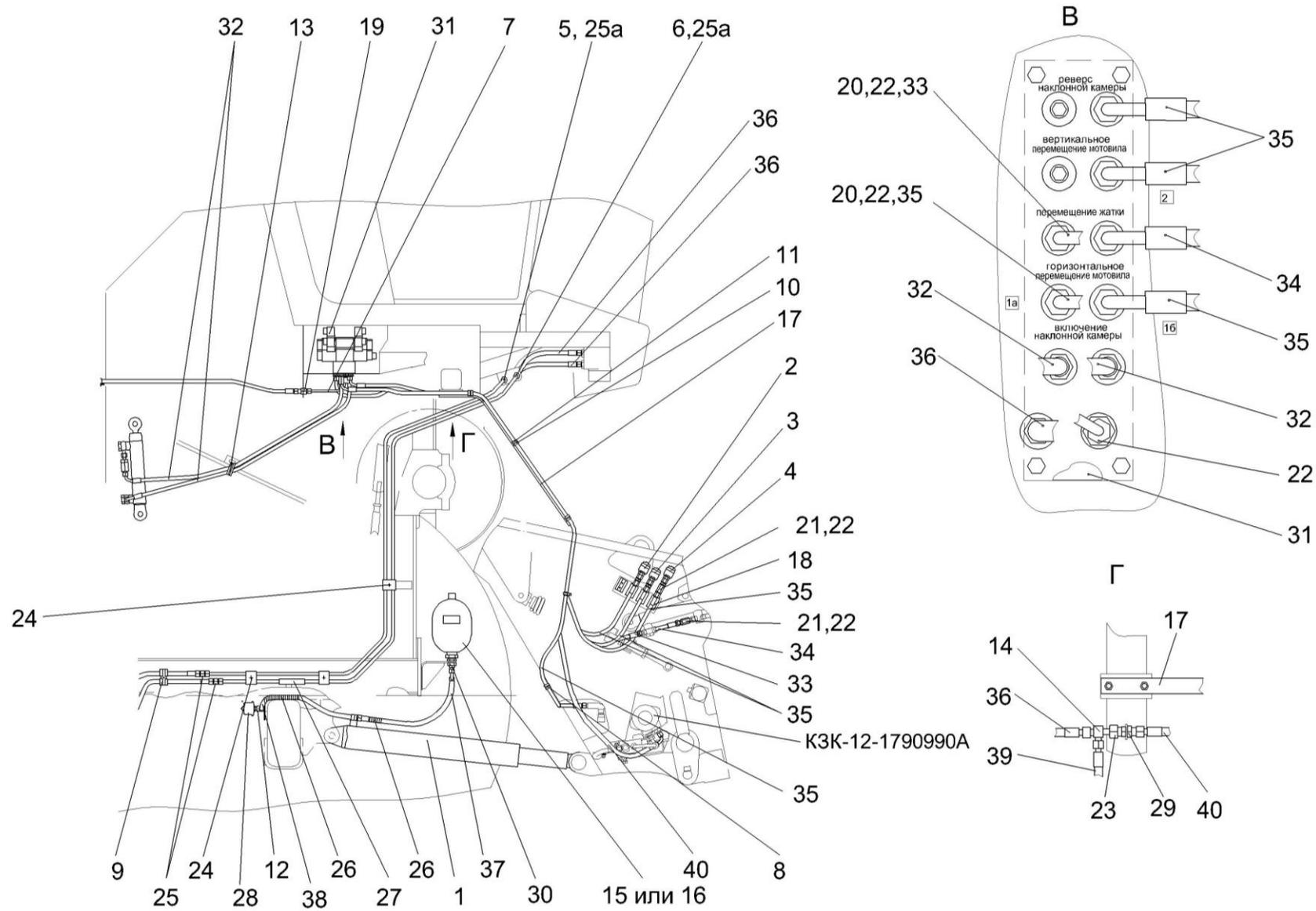
Рисунок 220 – Гидросистема рабочих органов и рулевого управления КЗК-12-0602000Б (вид справа) (лист 2)
