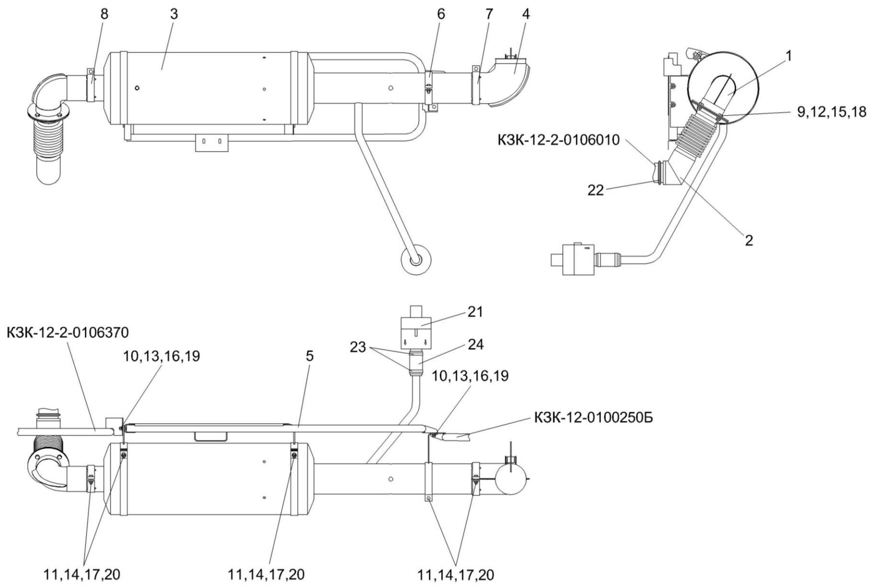
Рисунок 204 – Установка глушителя КЗК-12-2-0106310
