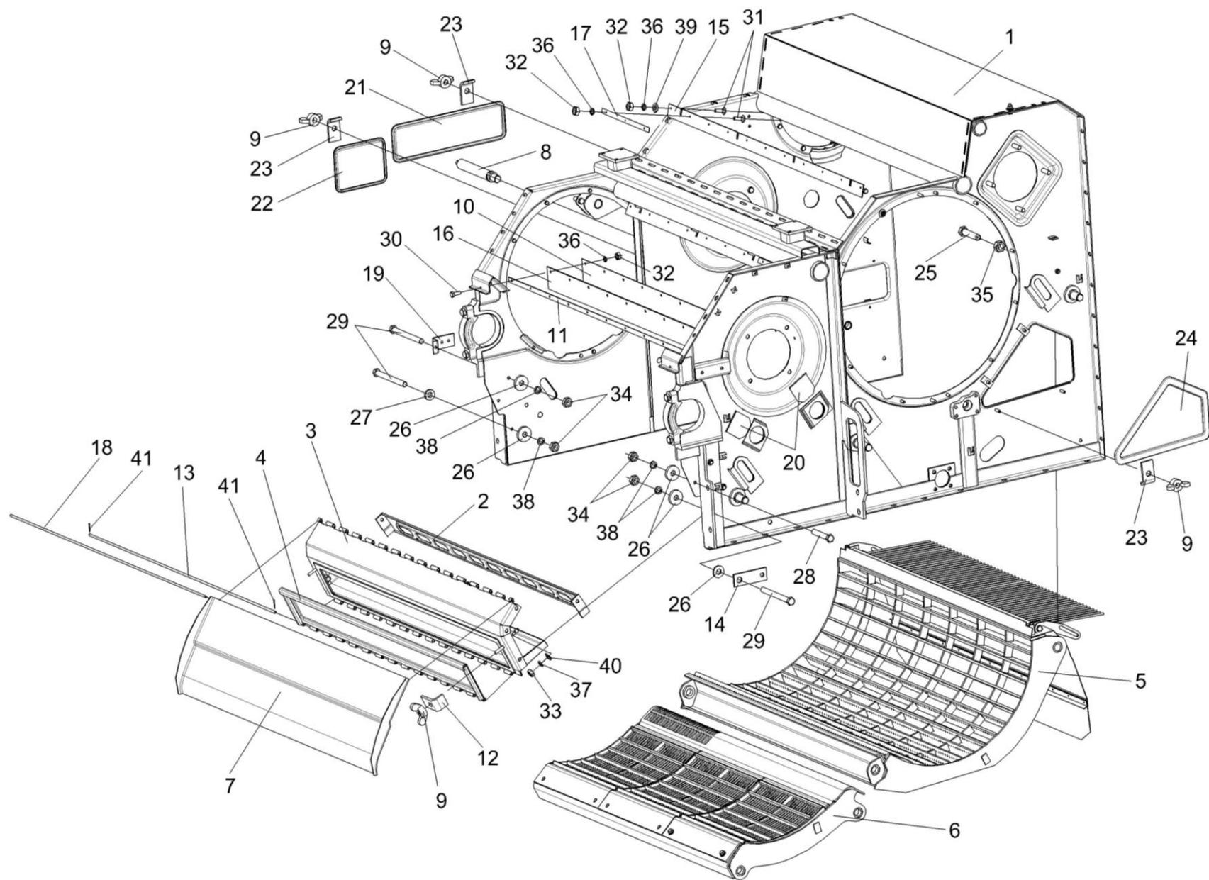
Рисунок 57 – Аппарат молотильный КЗК-12-1-0102000. Камнеуловитель, подбарабанья
