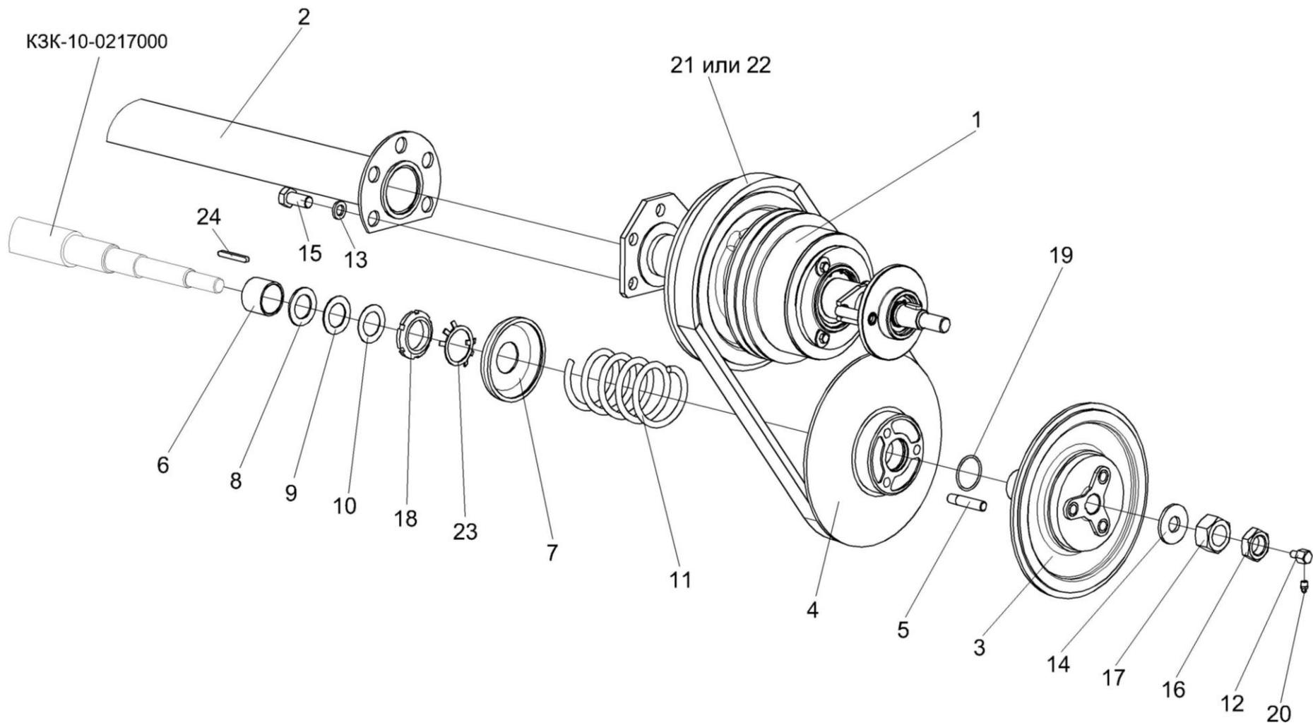
Рисунок 47 – Установка контрпривода вариатора K3K-12-0202500A
