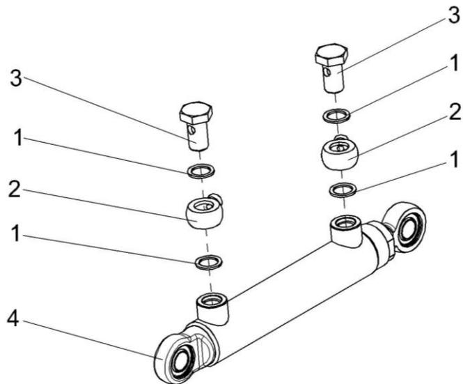
Рисунок 235 – Гидроцилиндр КЗК-12-0602730
