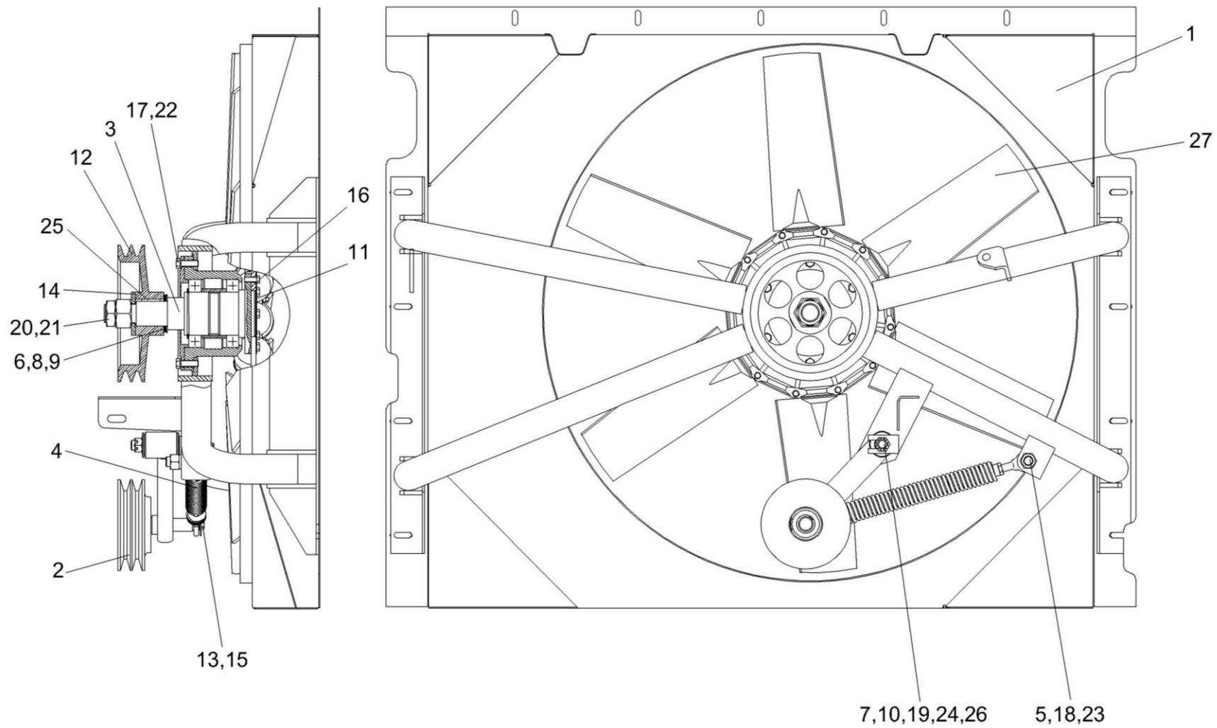
Рисунок 194 – Установка вентилятора КЗК-12-2-0106520
