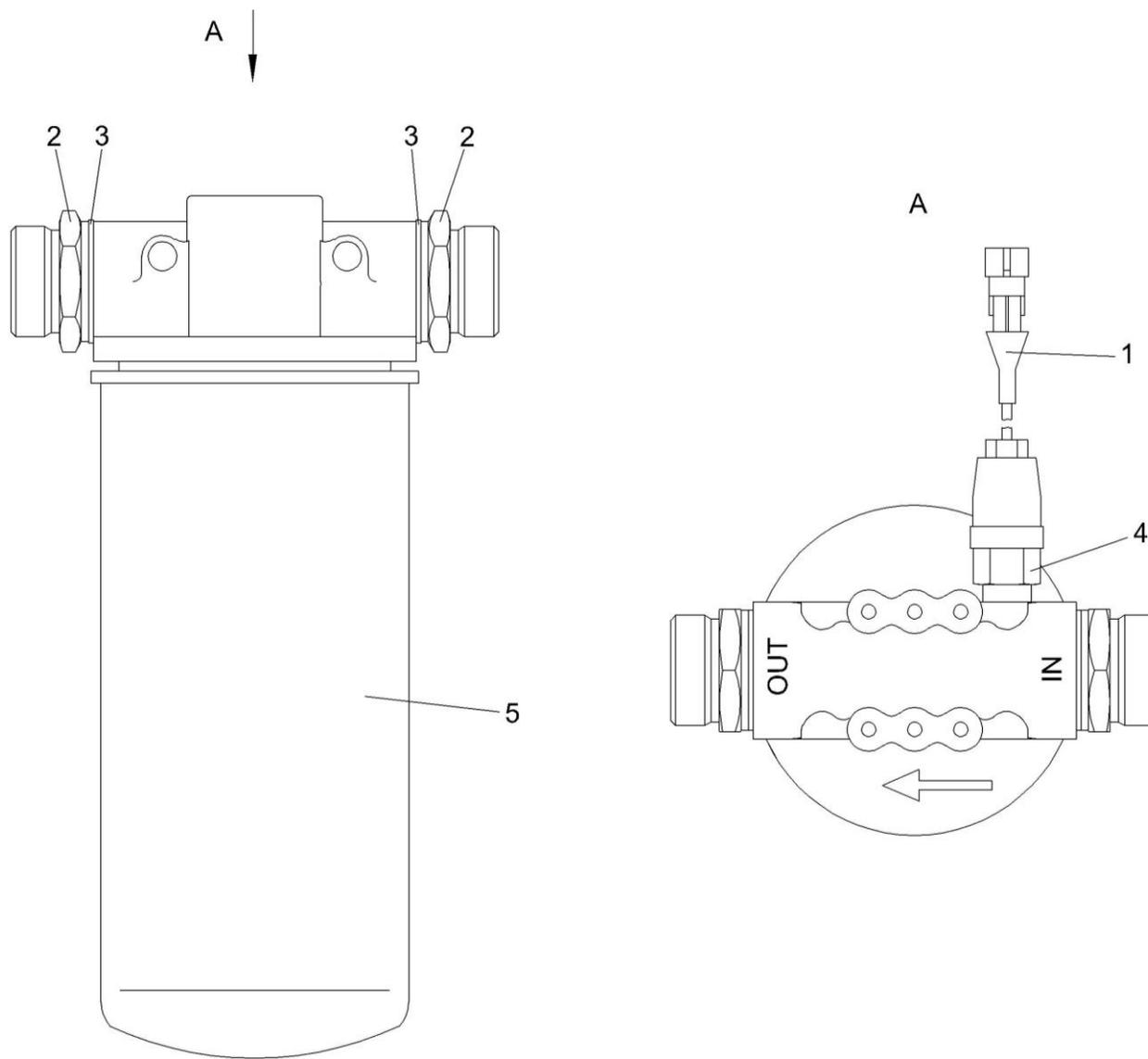
Рисунок 226 – Фильтр сливной КЗК-12-0602410
