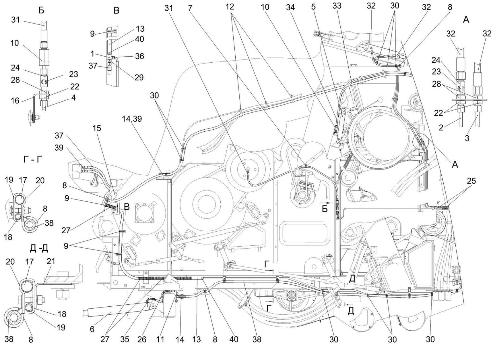
Рисунок 221 – Гидросистема рабочих органов и рулевого управления КЗК-12-0602000Б (вид сверху) (лист 1)
