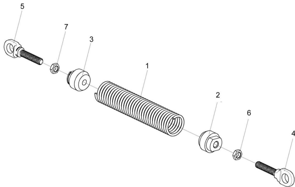
Рисунок 202 – Пружина КЗС 0131210
