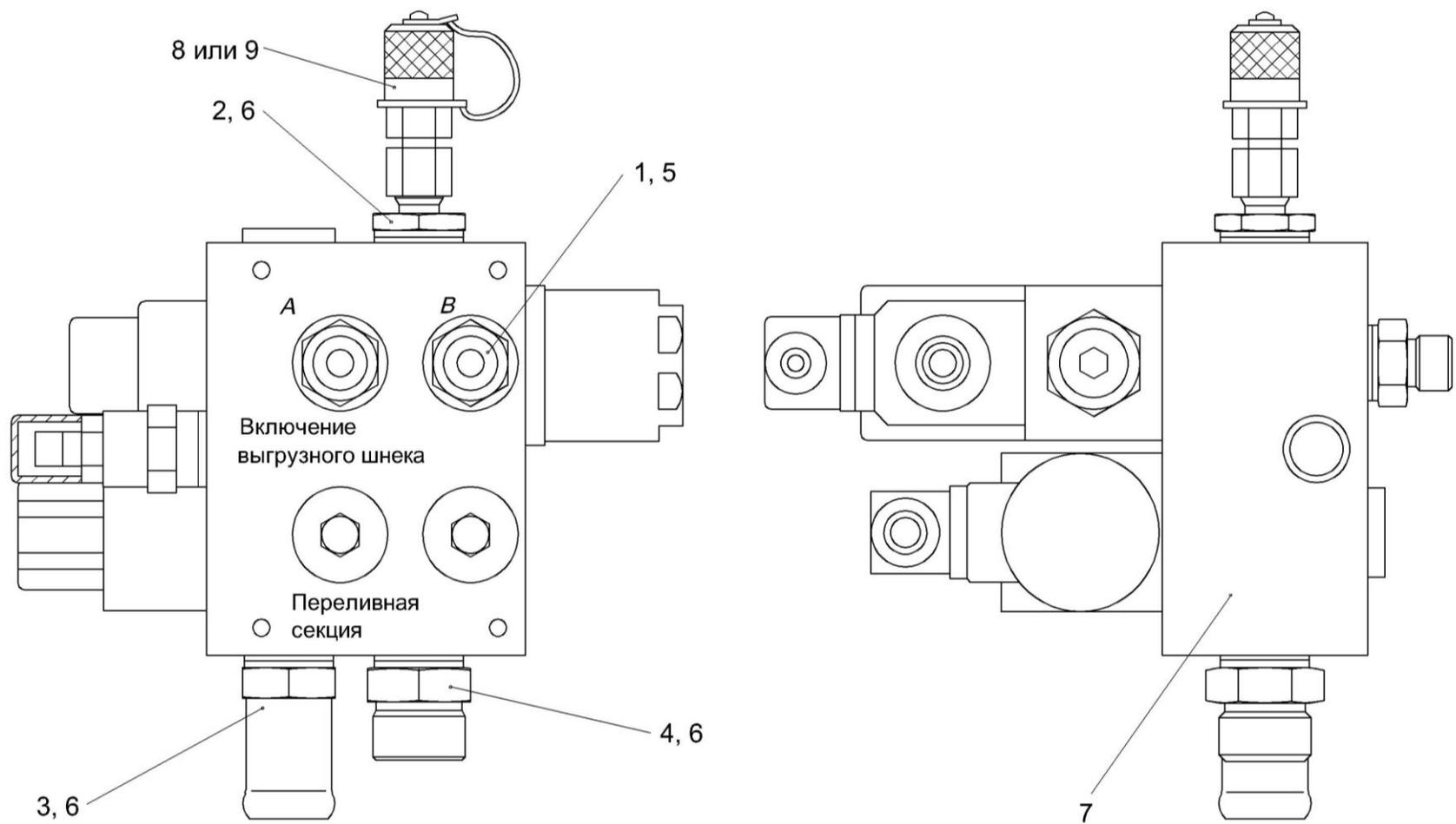
Рисунок 233 – Гидроблок двухсекционный КЗК-12-0602660
