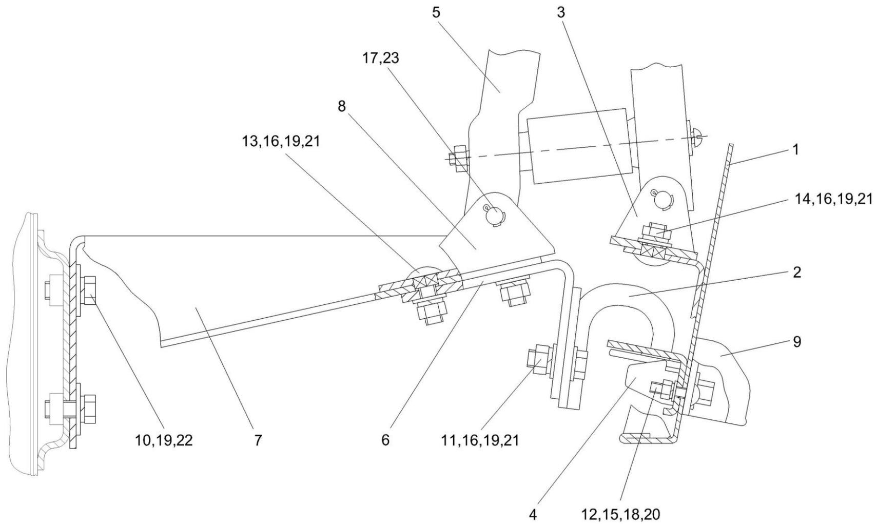
Рисунок 171 – Установка капота КЗК-12-0128110-01
