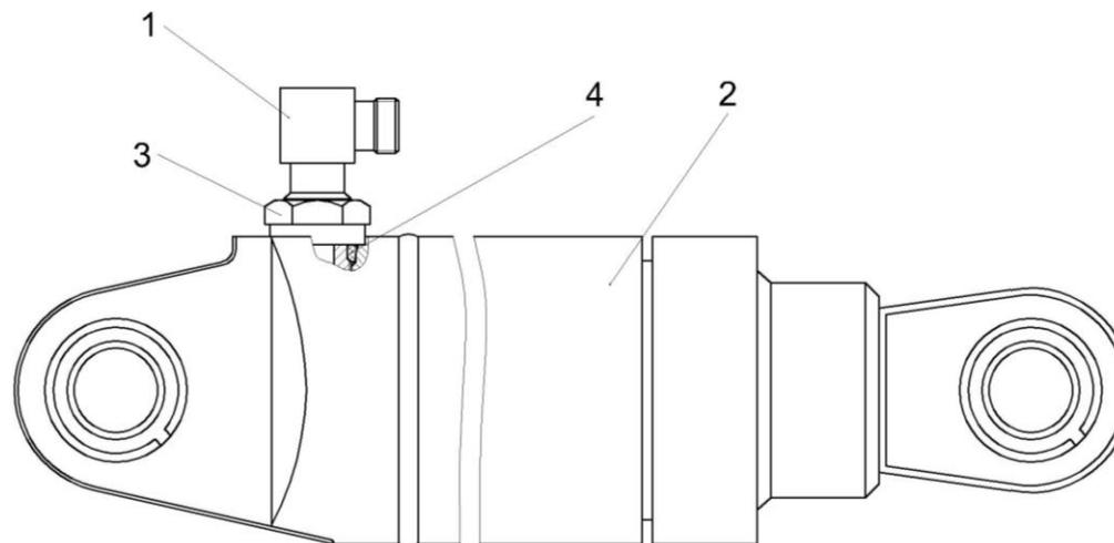
Рисунок 224 – Гидроцилиндр КЗК-12-0602740-01
