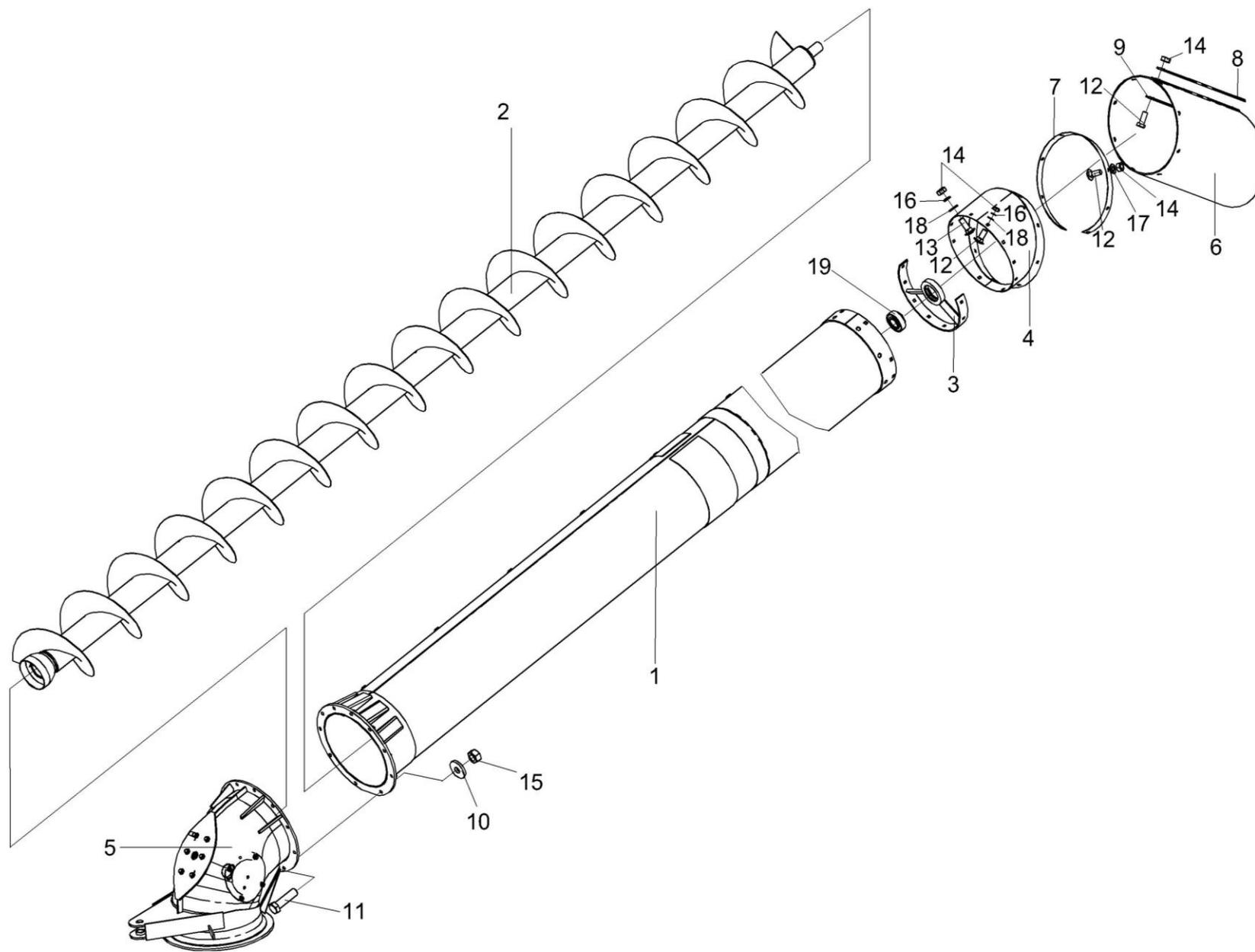
Рисунок 108 – Шнек с отводом КЗК-12-0206000А
