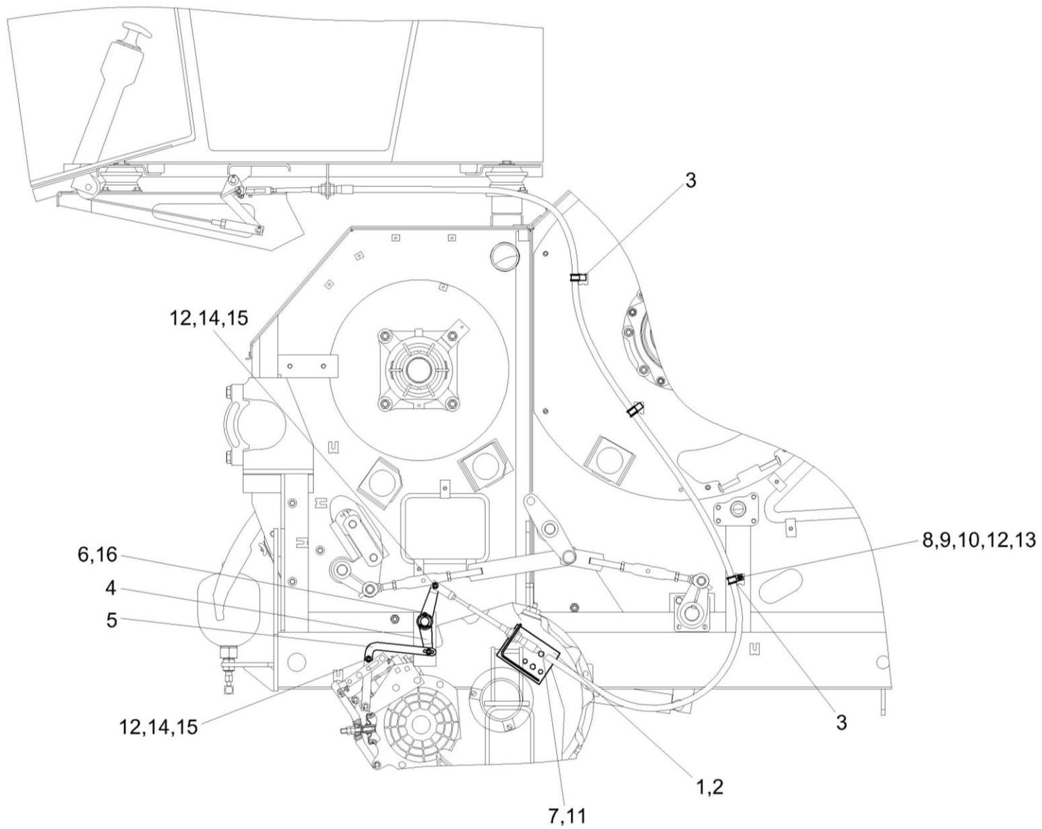
Рисунок 162 – Установка тросов управления стояночным тормозом КЗК-12-0119610
