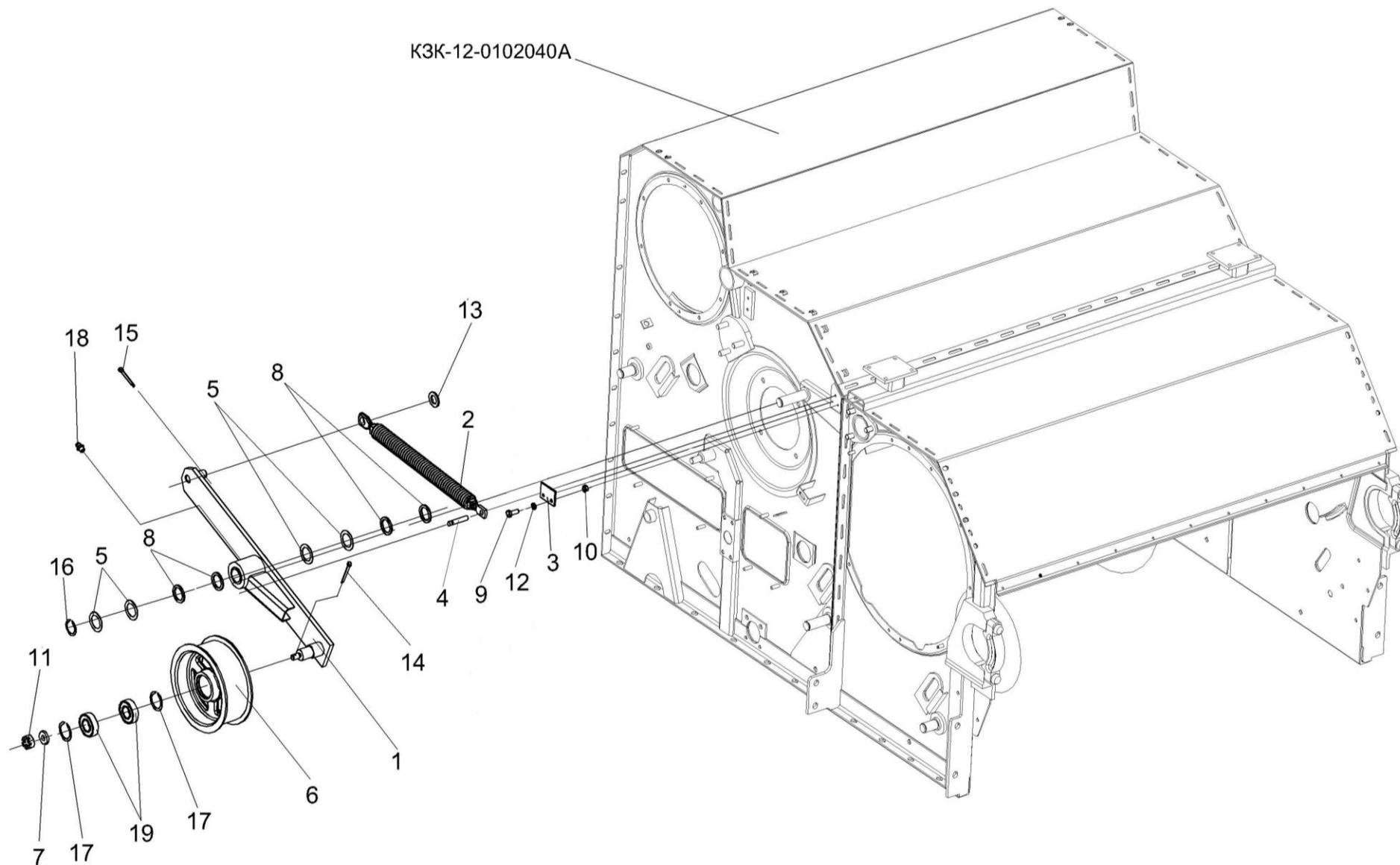
Рисунок 56 – Аппарат молотильный КЗК-12-1-0102000 (привод отбойного битера)
