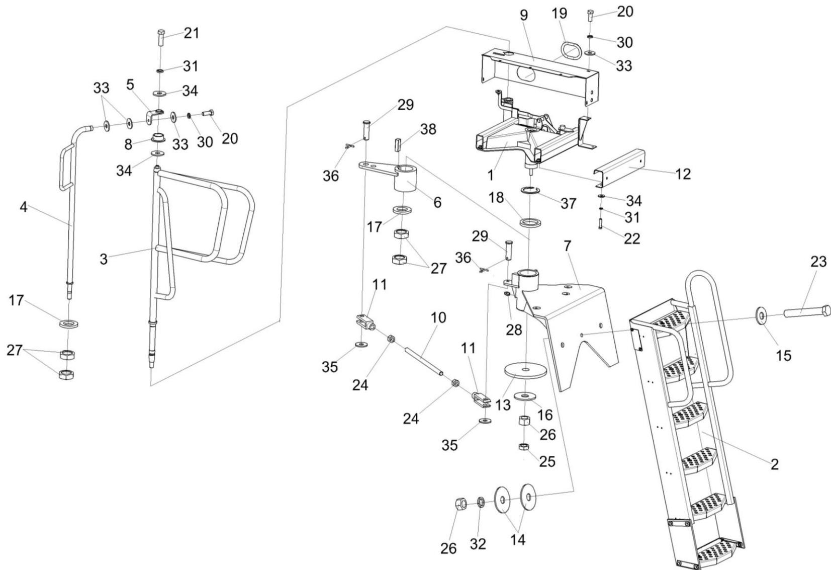
Рисунок 165 – Установка трапа КЗК-12-0117000А
