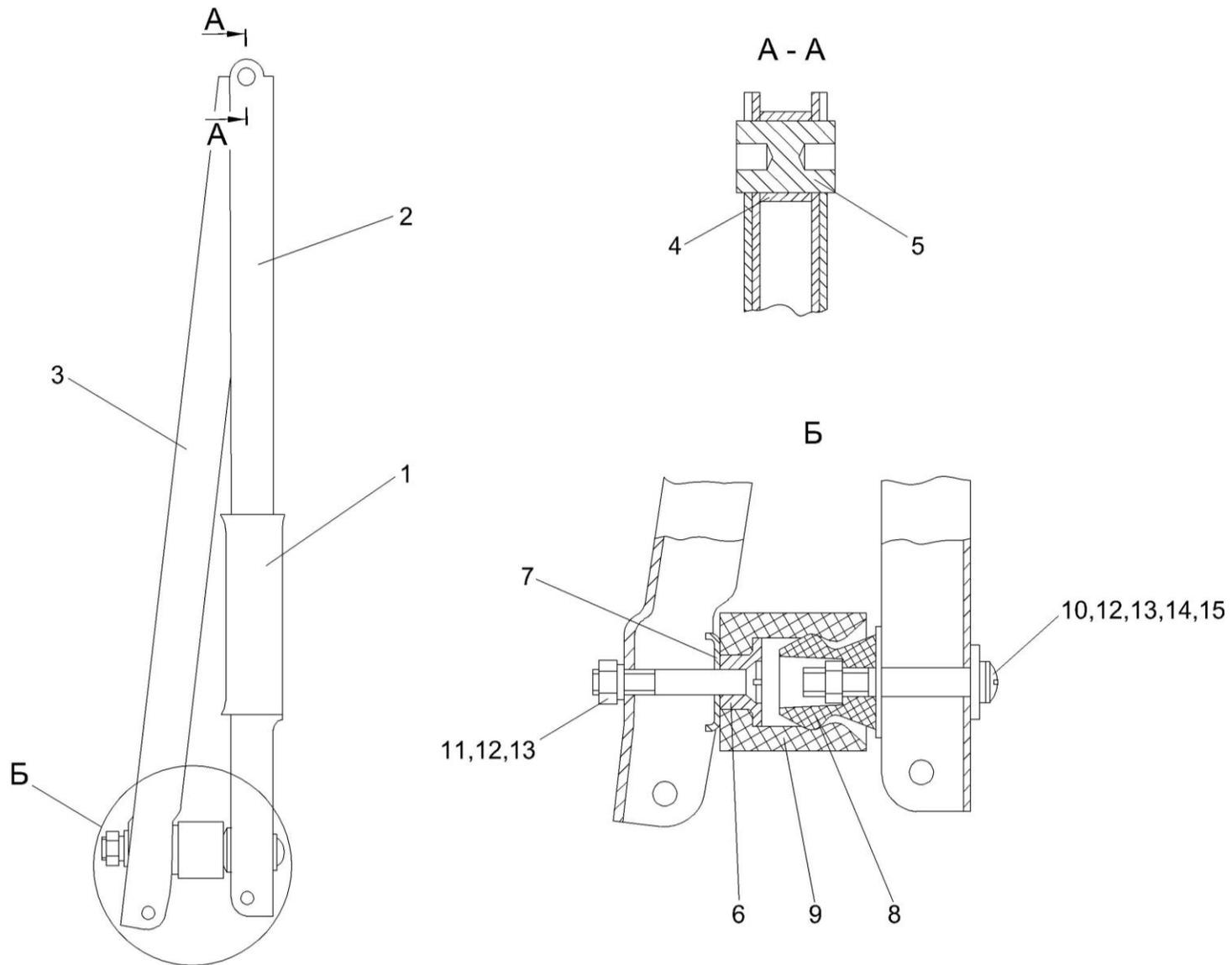
Рисунок 172 – Механизм фиксации капота КЗР 0200370В
