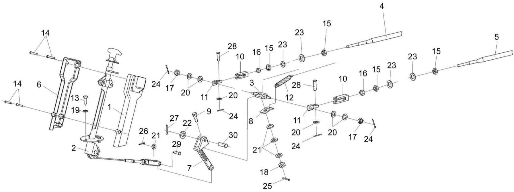
Рисунок 158 – Установка колонки привода УЭС 0300710
