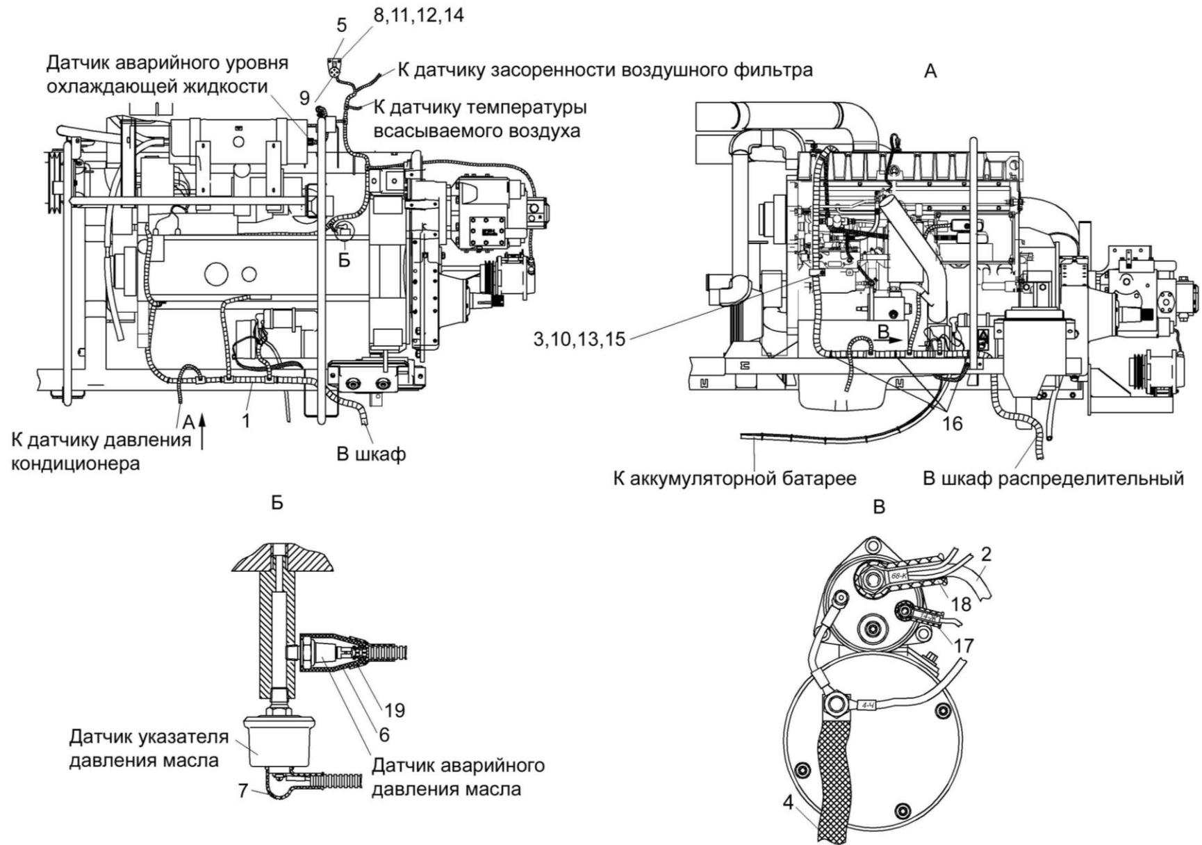
Рисунок 203 – Электрооборудование установки двигателя КЗК-12-2-0106000
