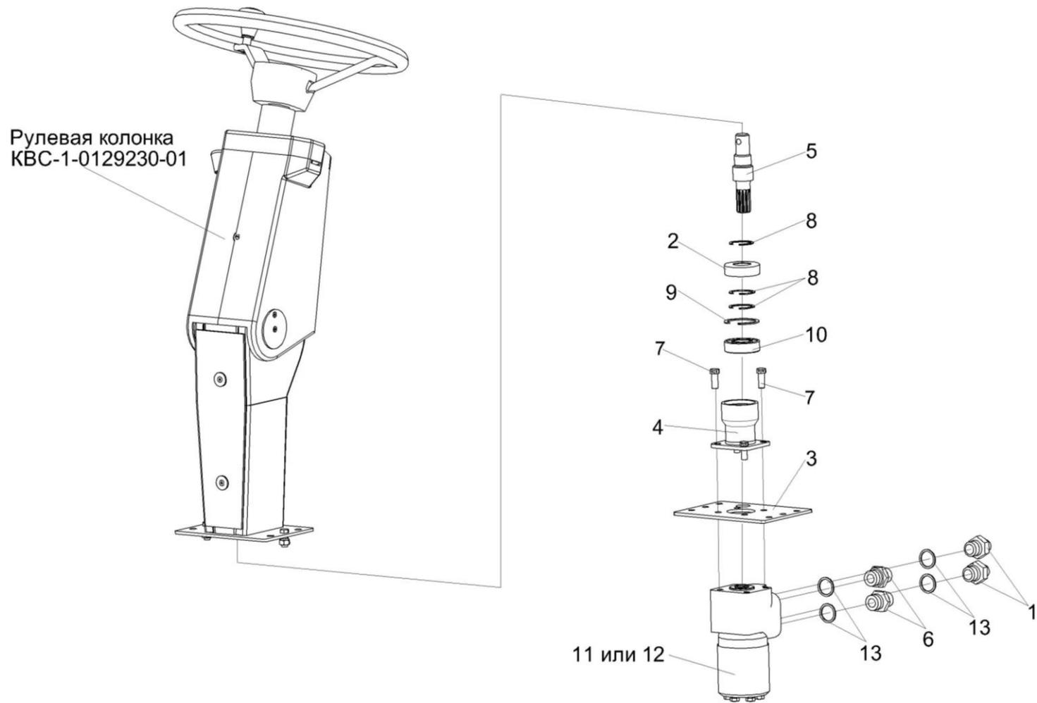
Рисунок 154 – Установка насоса-дозатора КЗК-10-0602090
