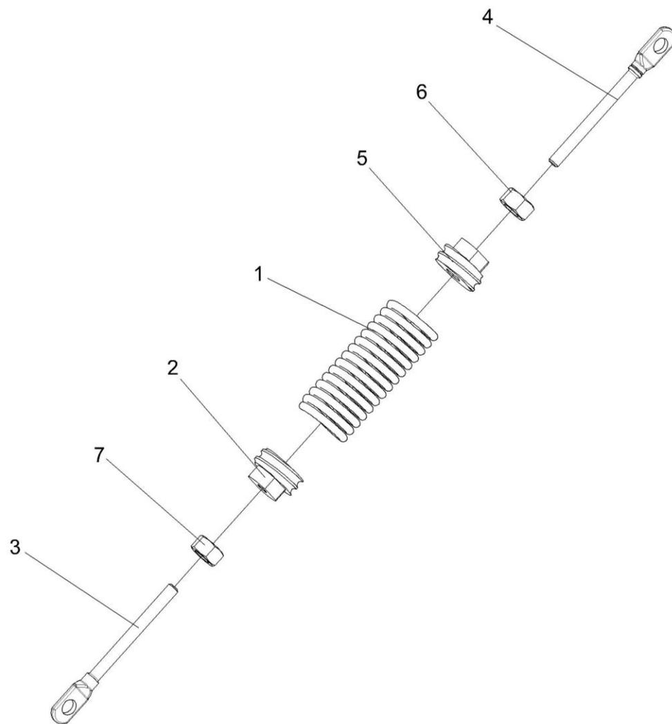
Рисунок 121 – Пружина КЗК-12-0221140
