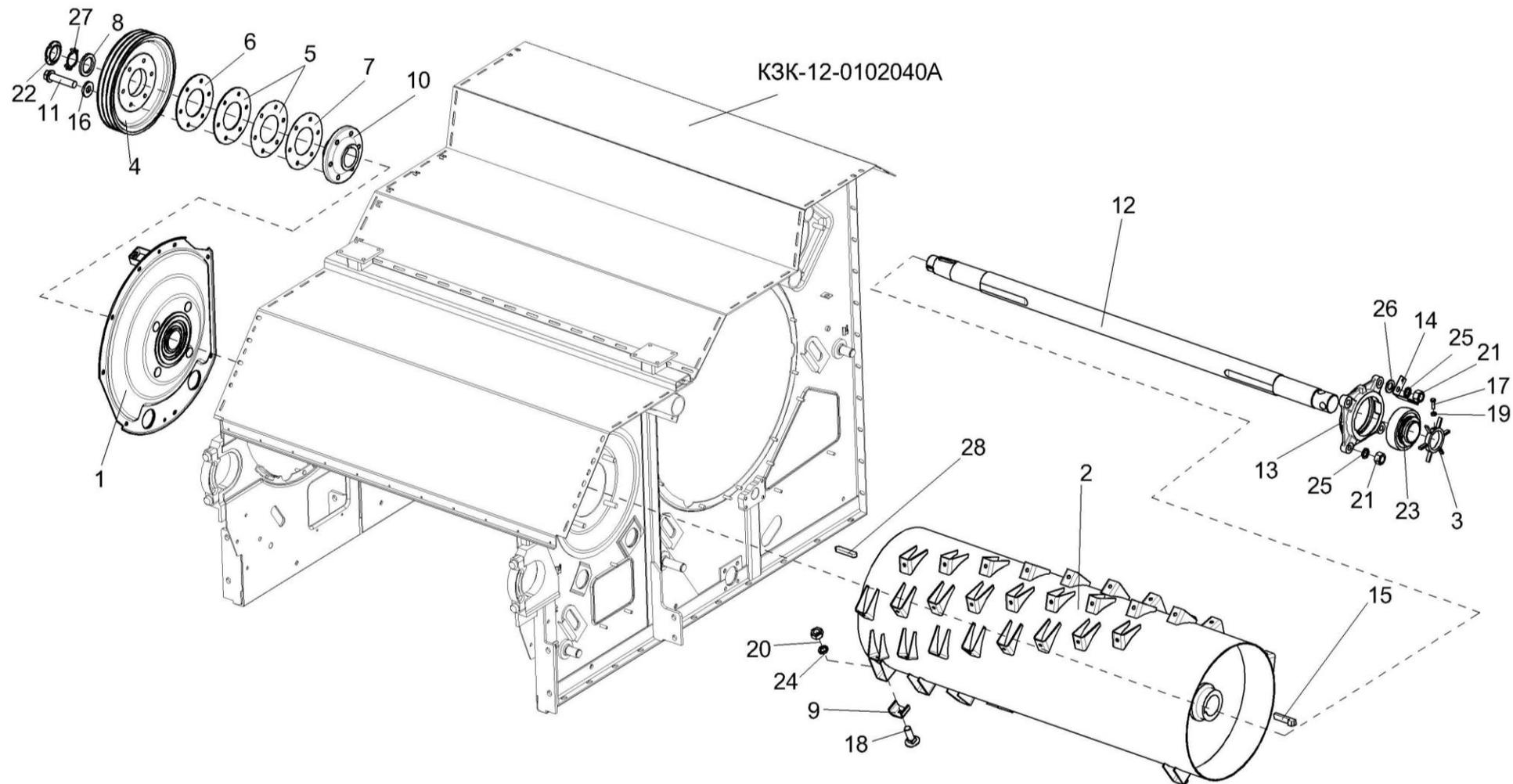
Рисунок 55 – Аппарат молотильный КЗК-12-1-0102000 (установка барабана ускоряющего)
