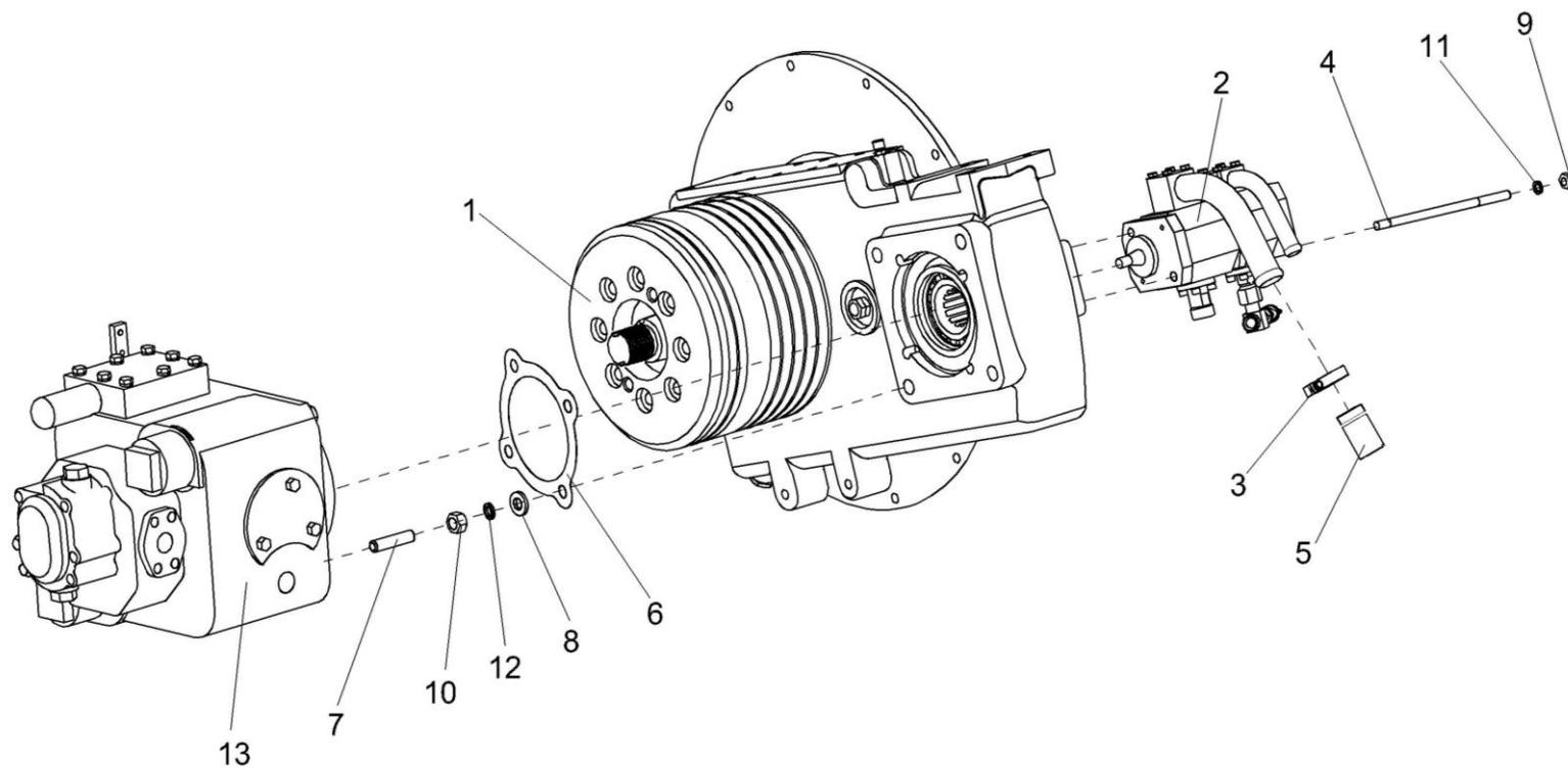
Рисунок 182 – Установка гидронасосов КЗК-12-3-0106730-01
