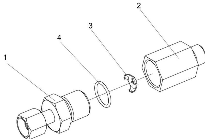
Рисунок 236 – Дроссели с обратным клапаном КЗК 0602520А, КЗК 0602520А-01
