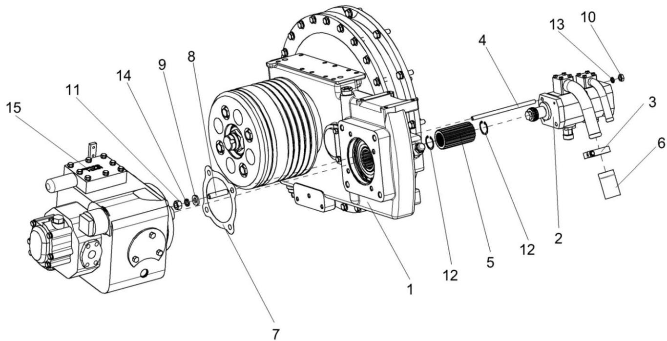
Рисунок 183 – Установка гидронасосов КЗК-12-3-0106740-01
