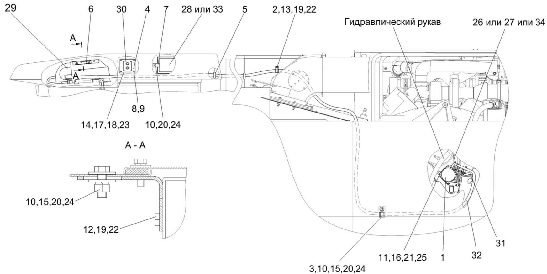
Рисунок 138 – Установка климатическая КЗК-12-0113000Б (лист 2)
