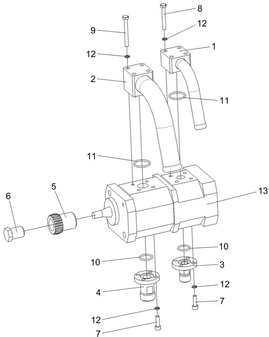
Рисунок 187 – Гидронасос двухсекционный КЗК-12-0602940А
