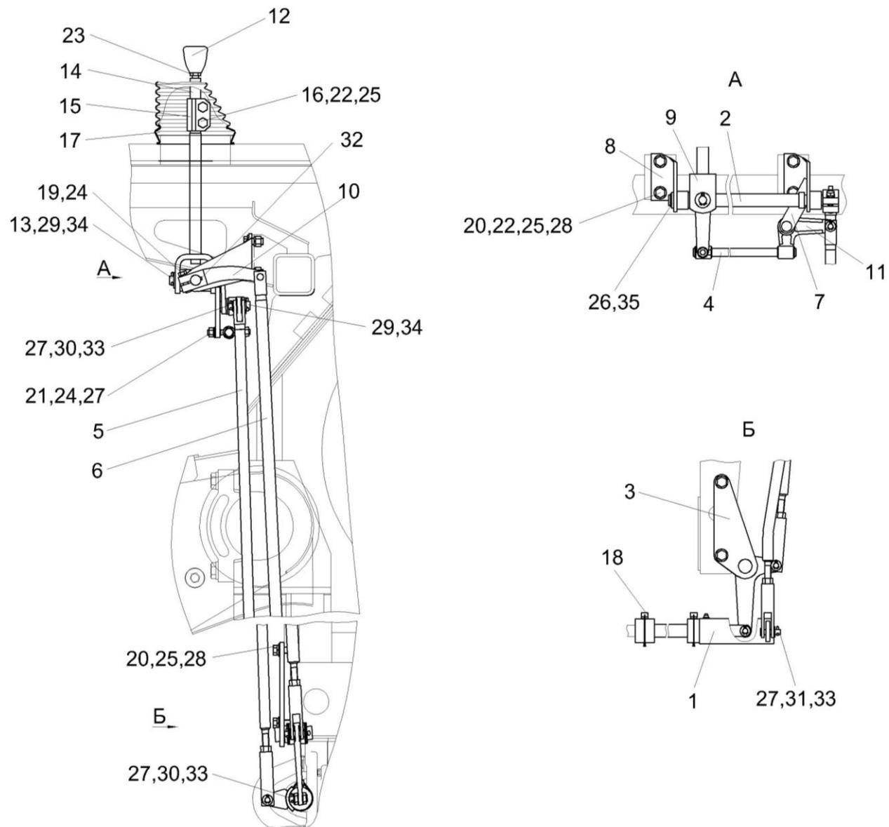
Рисунок 160 – Установка механизма управления коробкой диапазонов КЗК-12-0119040А-01
