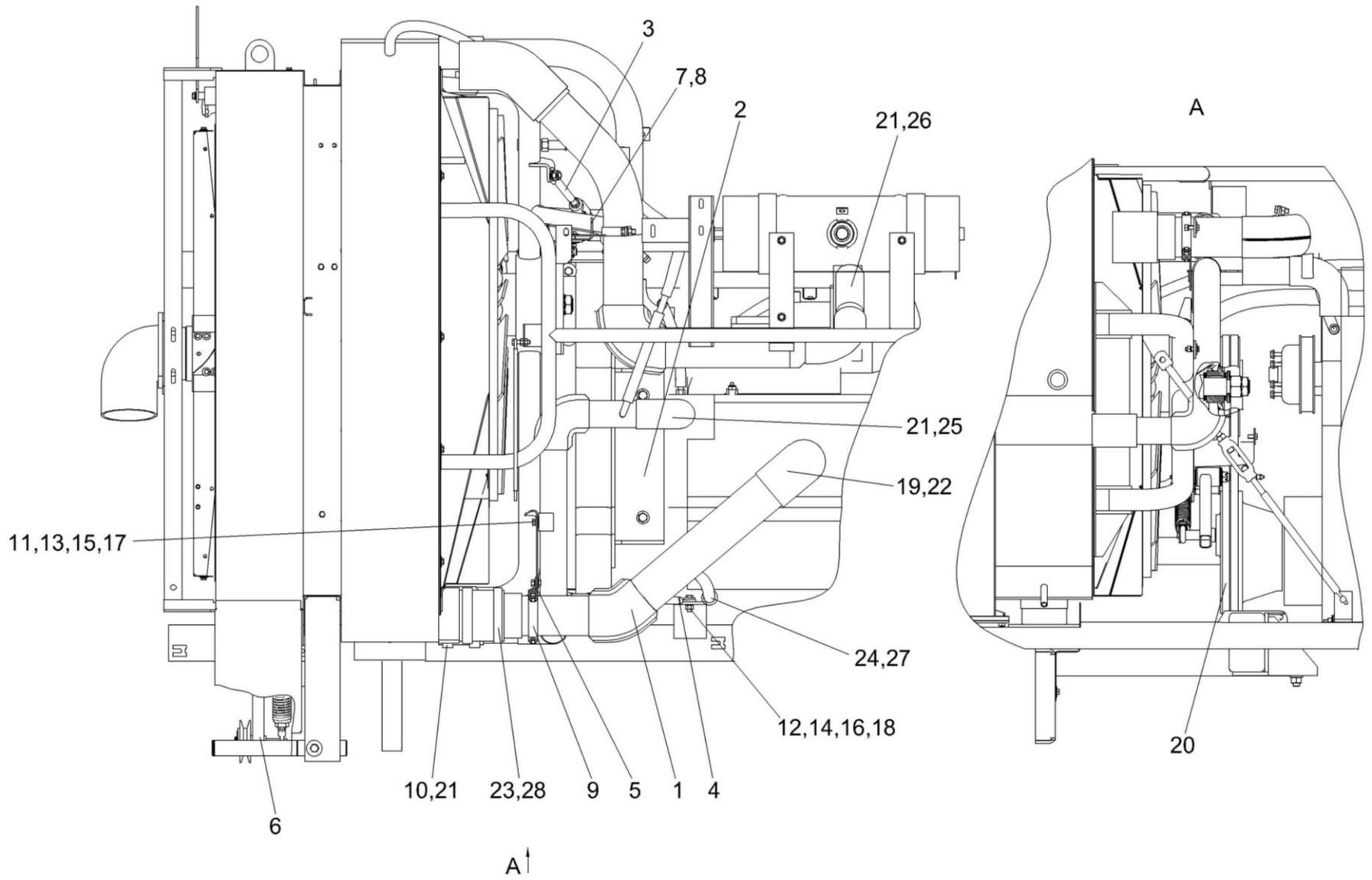
Рисунок 180 – Установка двигателя КЗК-12-2-0106000 (вид сверху)
