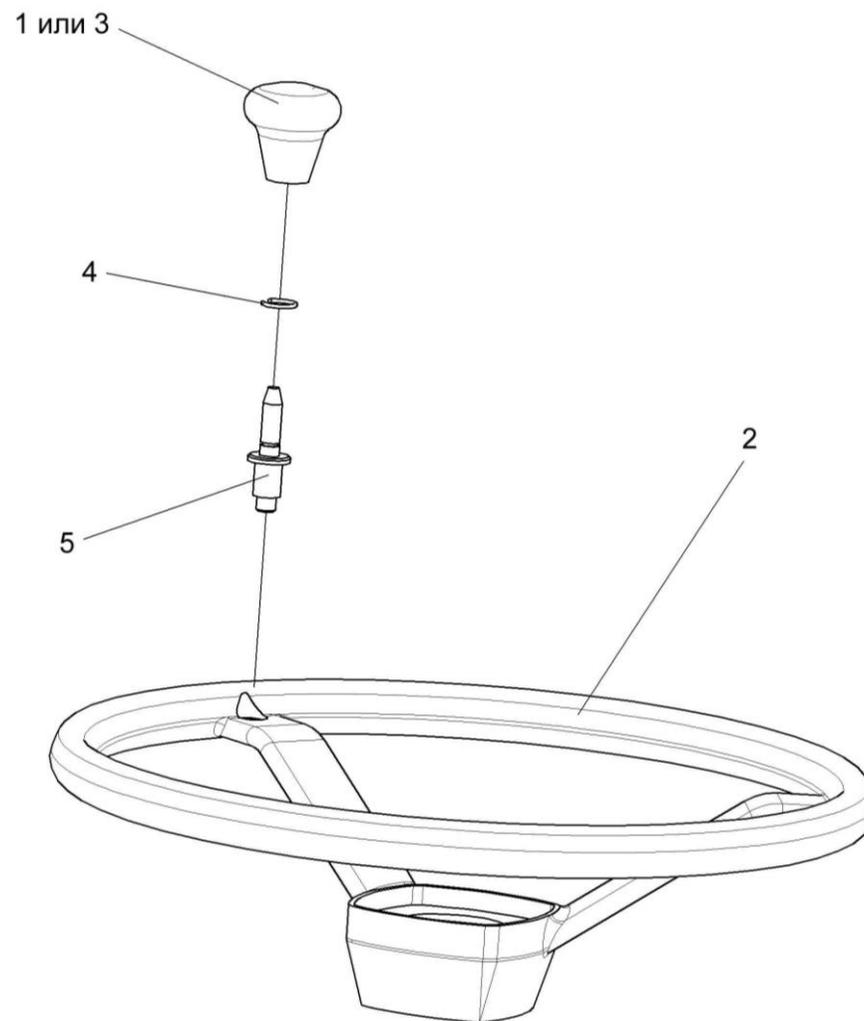
Рисунок 156 – Колесо рулевое УЭС 0302560
