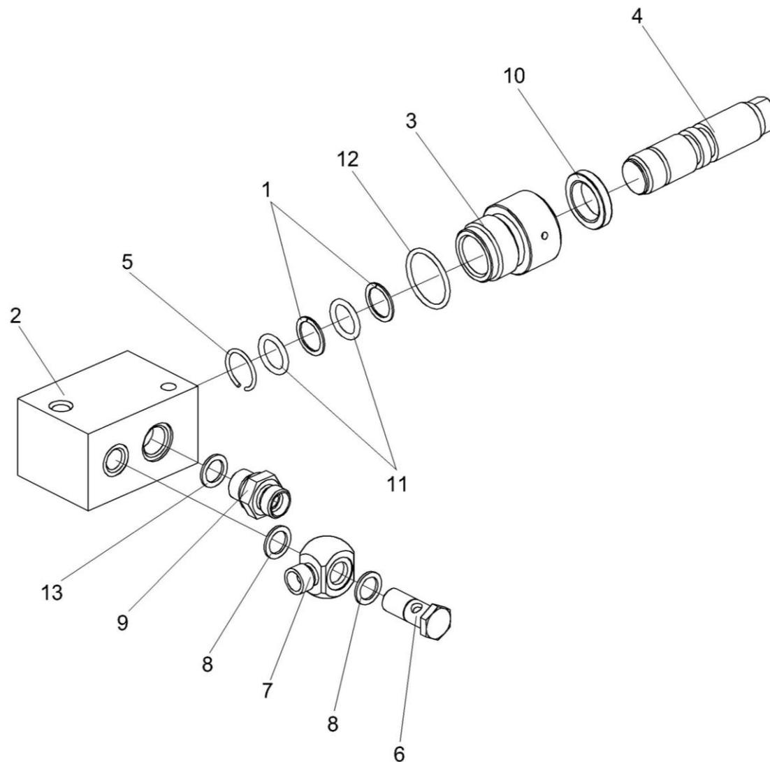
Рисунок 20 – Гидроцилиндр КЗК-12-1790200А
