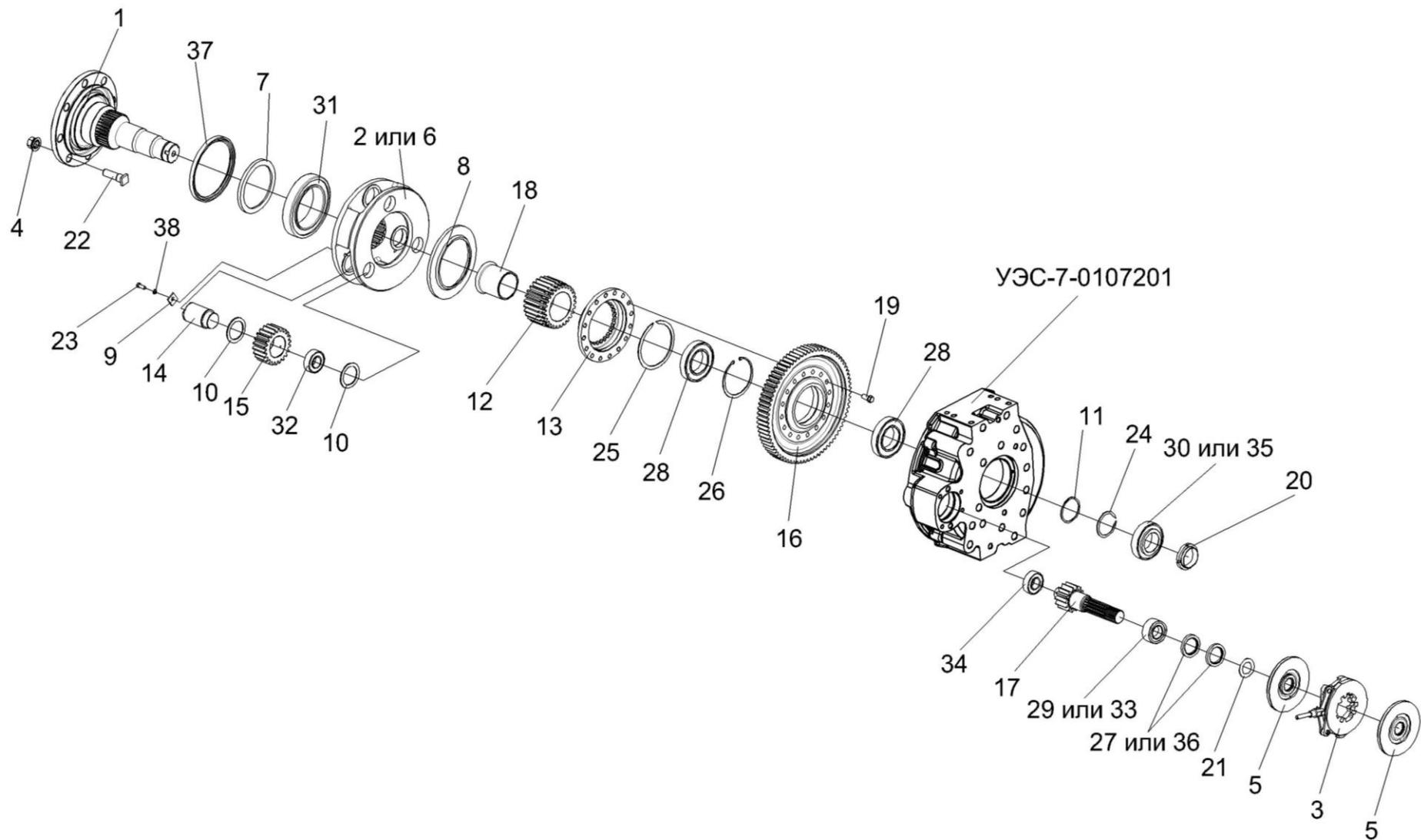
Рисунок 71 – Редуктор бортовой КЗК-10-0107200. Валы и шестерни
