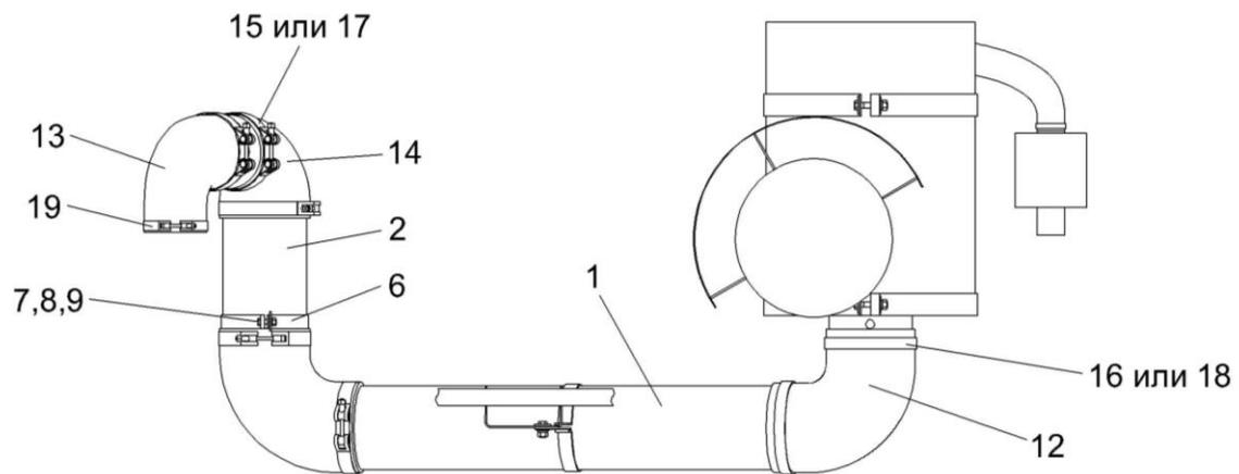
Рисунок 206 – Установка воздухоочистителя КЗК-12-2-0106320А
