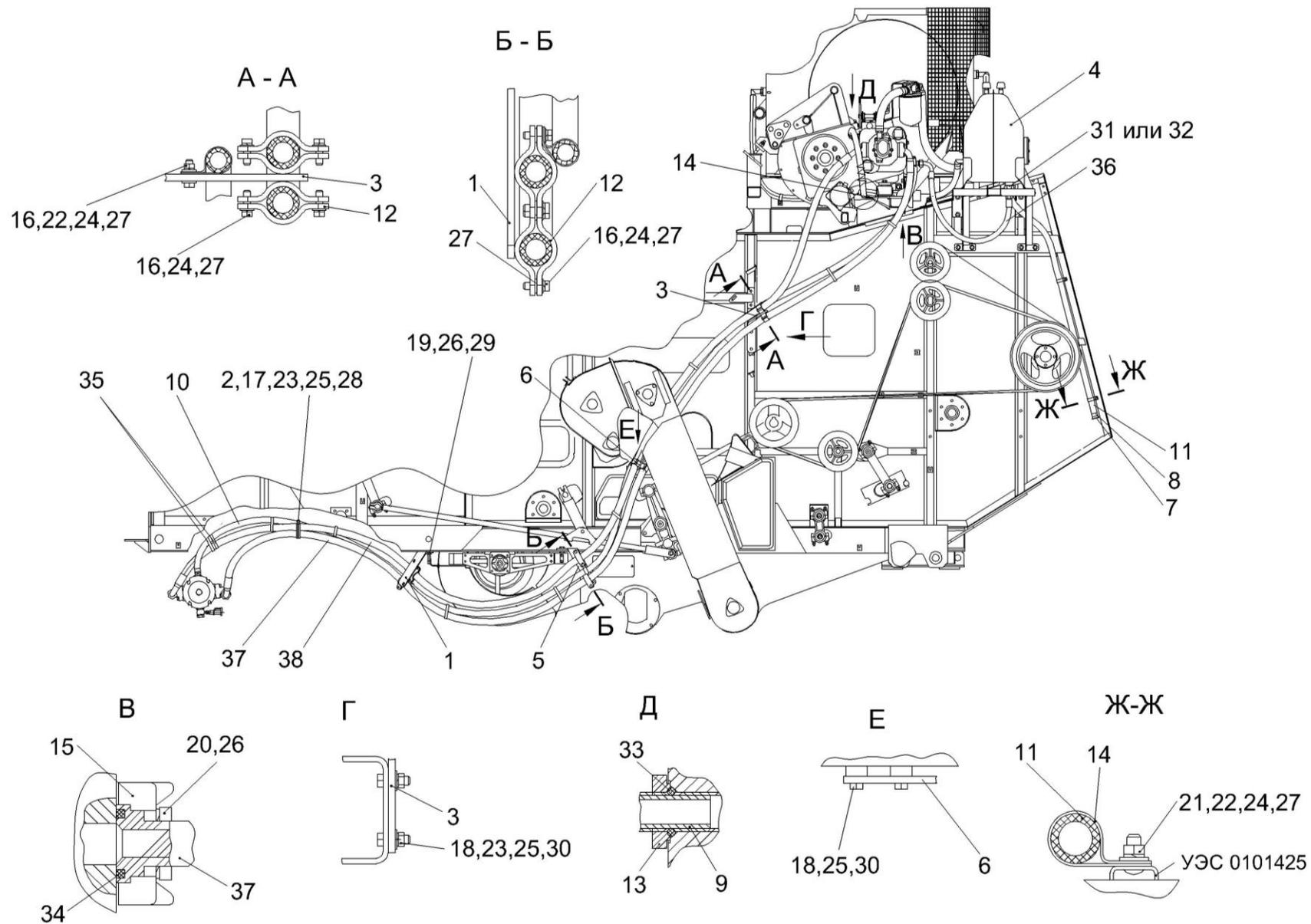
Рисунок 213 – Гидросистема привода ходовой части КЗК-12-0601000Б (вид слева)
