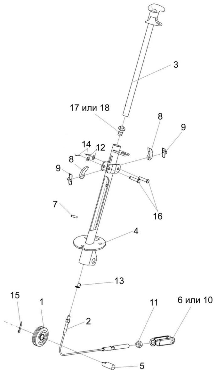
Рисунок 159 – Колонка привода УЭС 0300710
