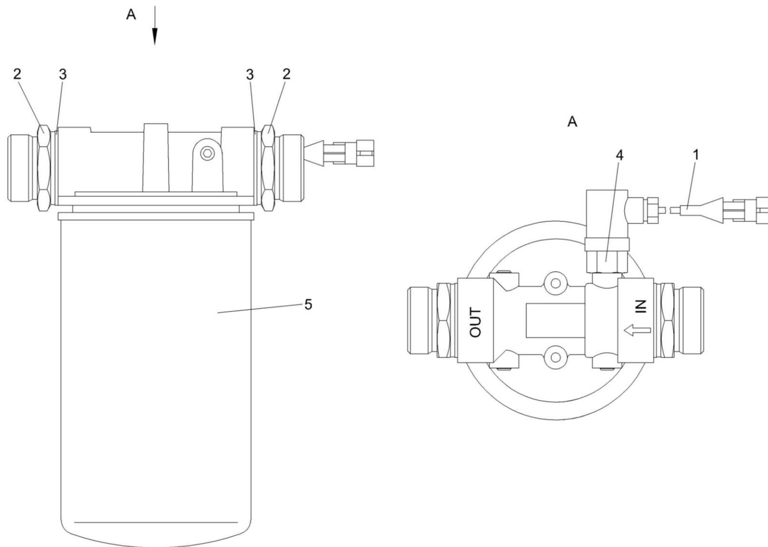
Рисунок 227 – Фильтр сливной КЗК-12-0602420
