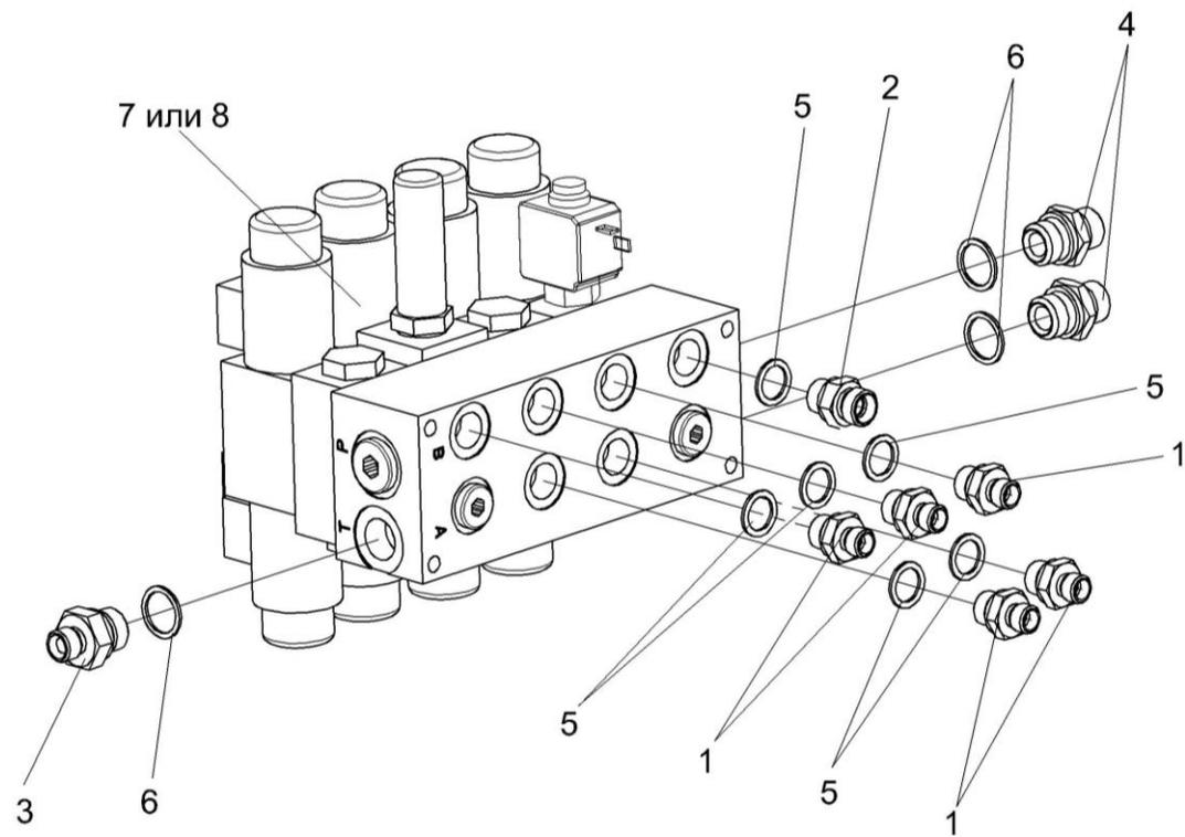
Рисунок 232 – Гидроблок четырехсекционный КЗК-12-0602650
