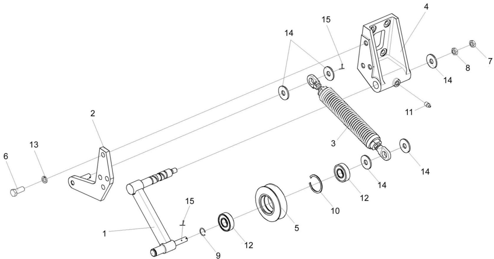
Рисунок 201 – Устройство натяжное КЗК-10-0112010
