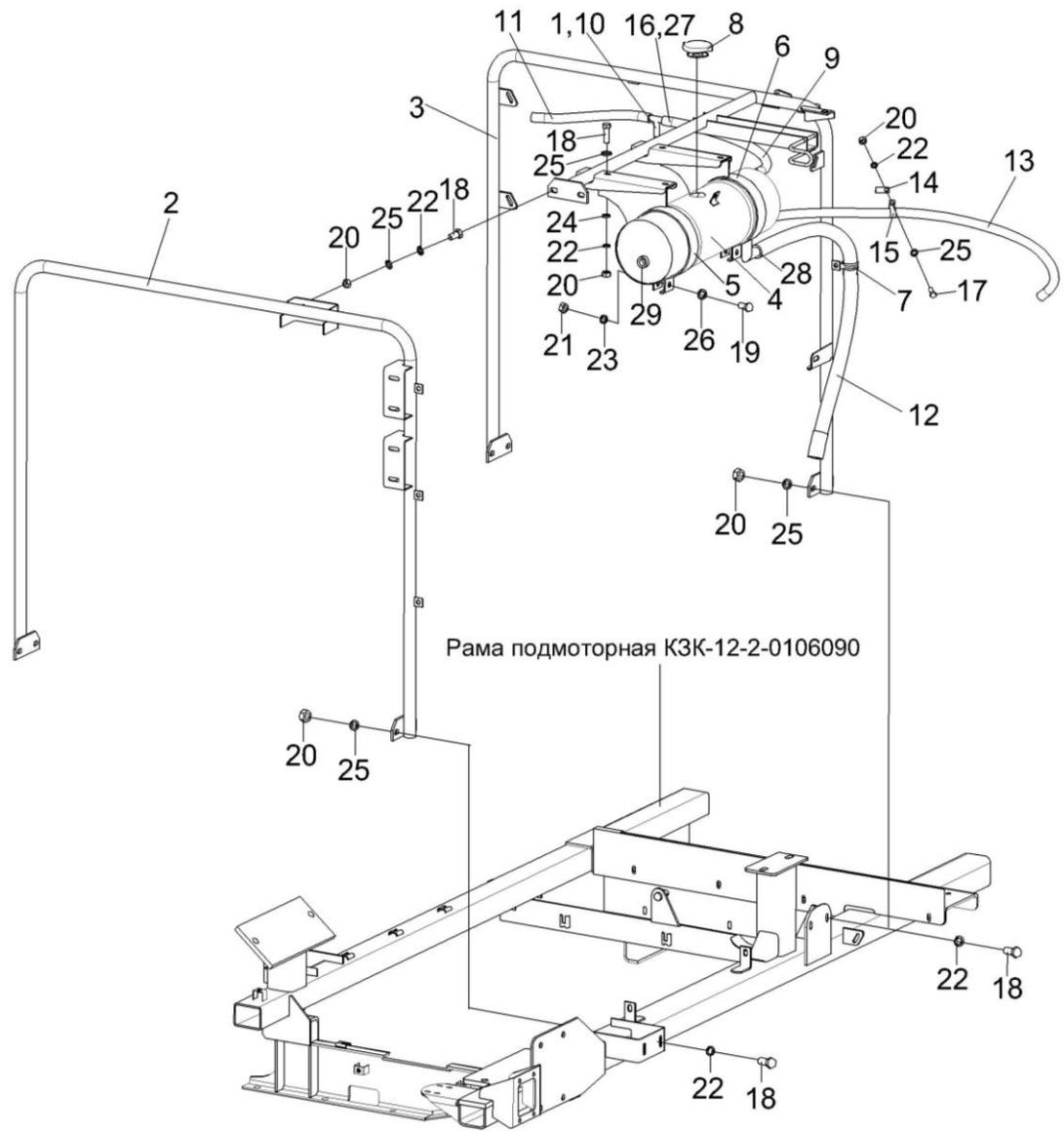
Рисунок 191 – Установка бачка расширительного КЗК-12-2-0106070
