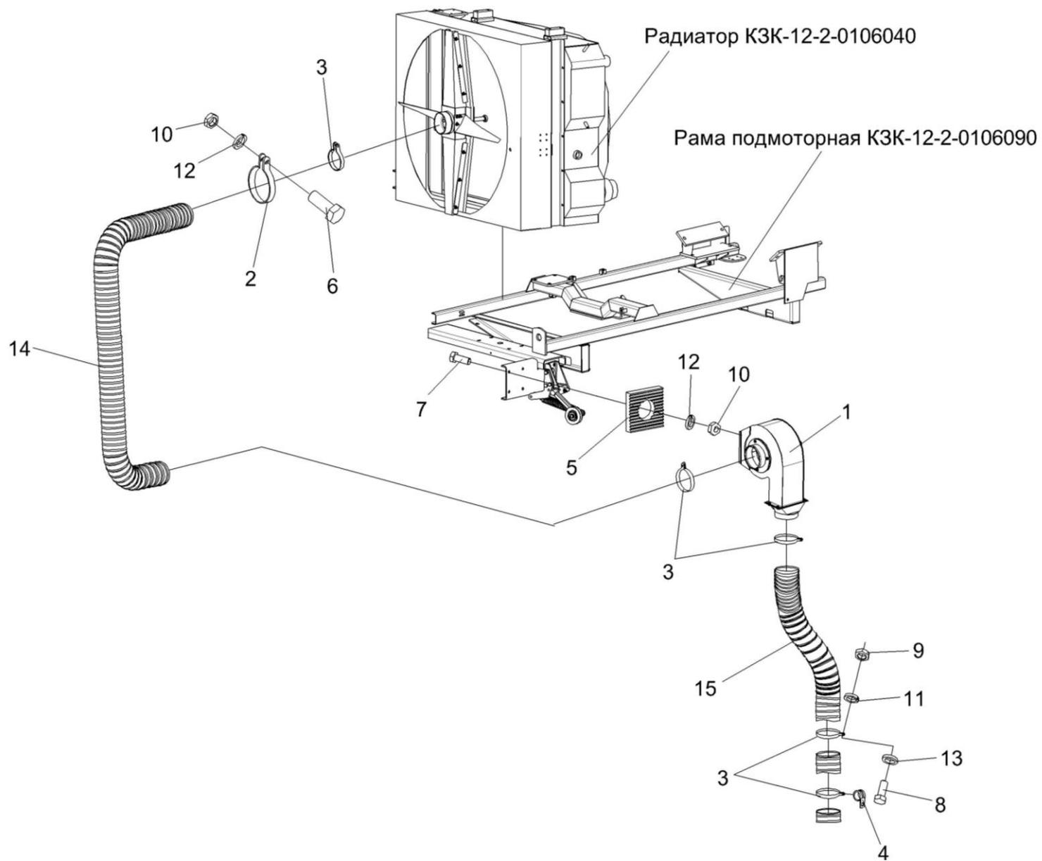
Рисунок 207 – Установка вентилятора КЗК-12-3-0112240
