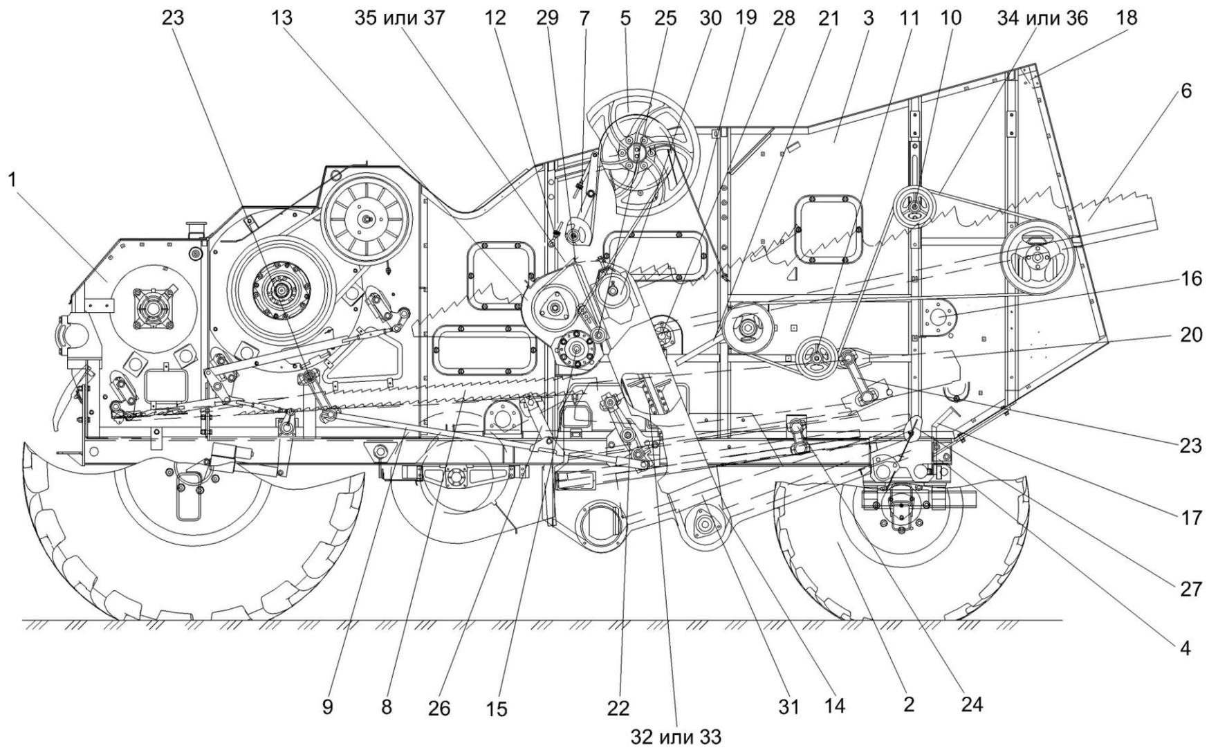
Рисунок 32 – Очистка КЗК-12-0202000Б-03 (вид слева)
