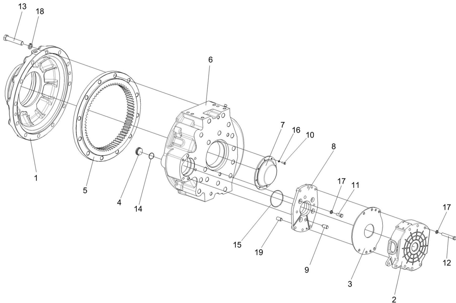
Рисунок 70 – Редуктор бортовой КЗК-10-0107200. Корпуса и крышки
