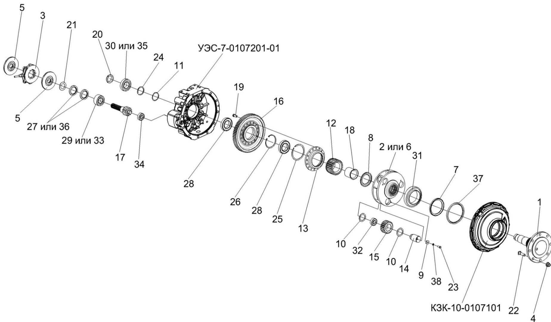
Рисунок 74 – Редуктор бортовой КЗК-10-0107200-04. Валы и шестерни
