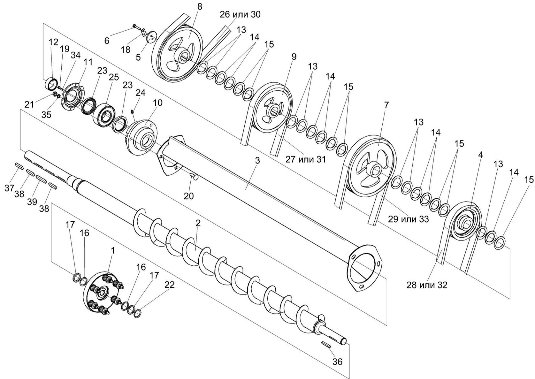
Рисунок 35 – Установка шкивов на шнек КЗК-10-0202770
