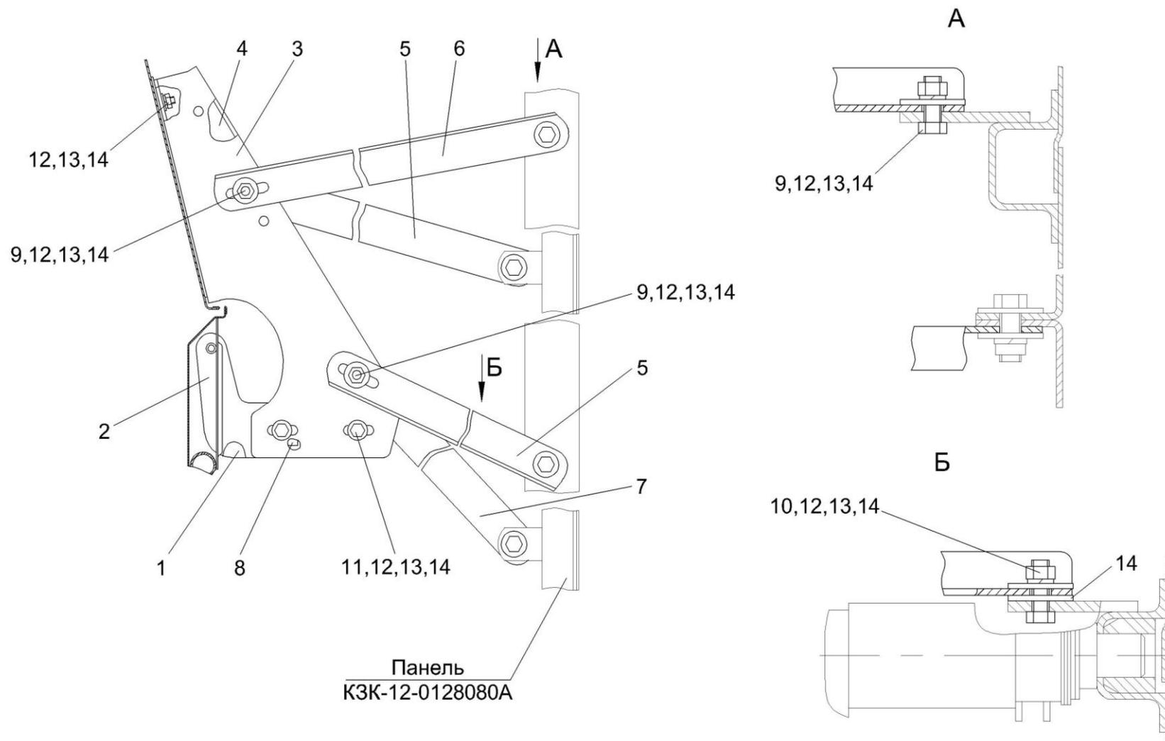
Рисунок 175 – Установка кронштейна КЗК 0128420-01
