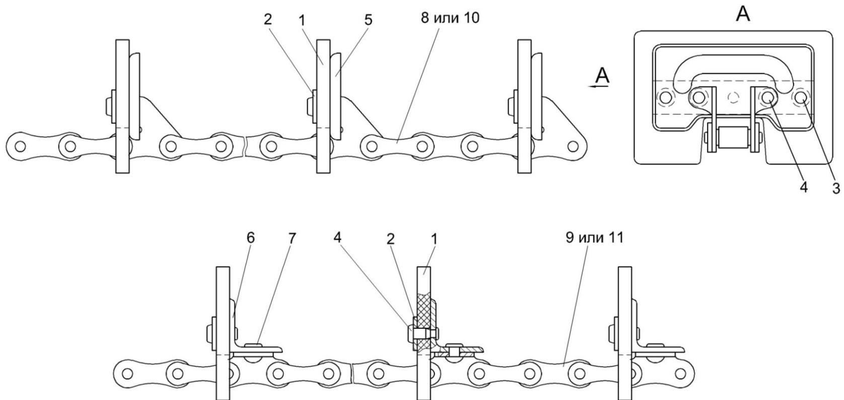
Рисунок 114 – Цепи элеватора КЗК-10-0214140 и КЗК-10-0214160
