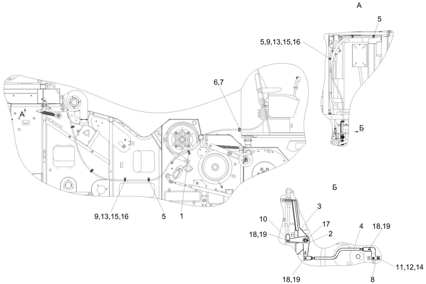
Рисунок 163 – Установка троса управления гидронасосом хода КЗК-12-0119620Б
