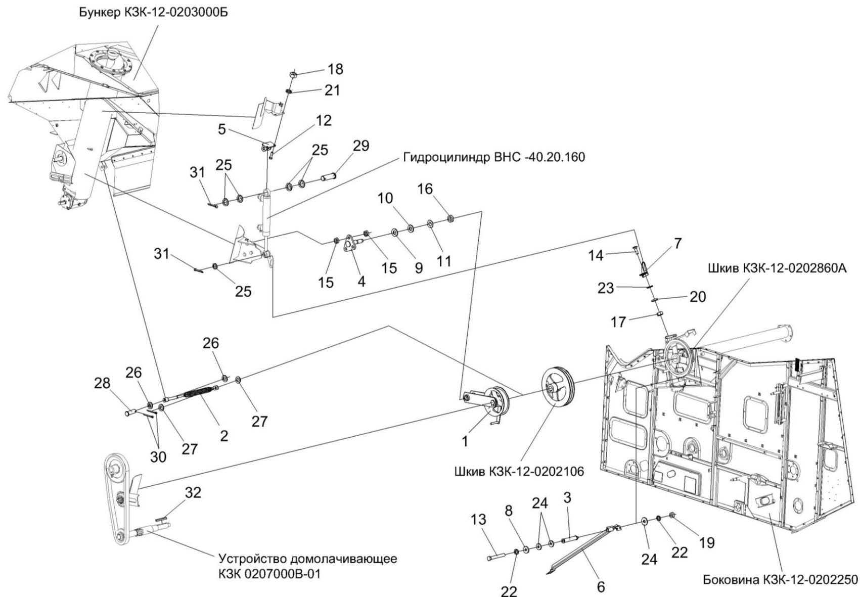
Рисунок 118 – Привод выгрузки КЗК-12-0221100А (лист 1)
