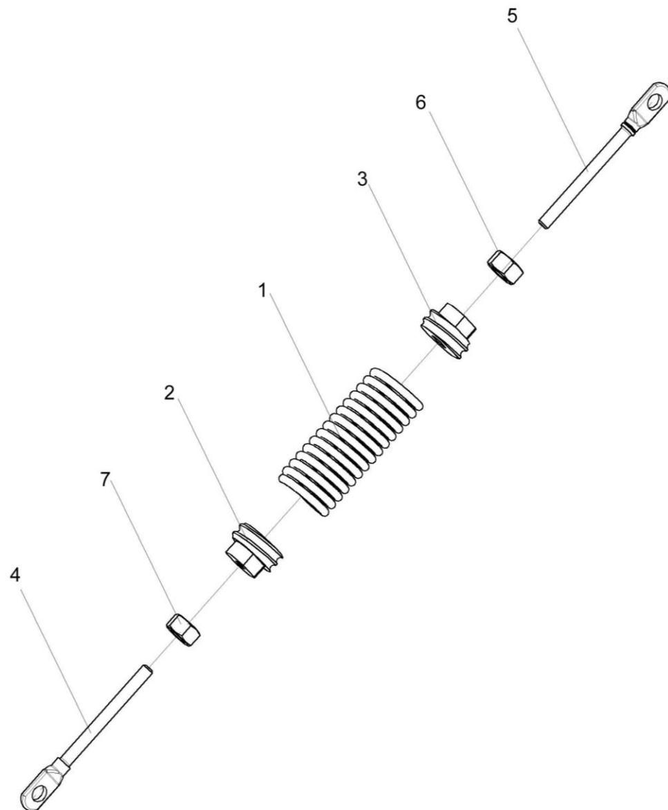
Рисунок 210 – Пружина КЗК-12-3-0220050
