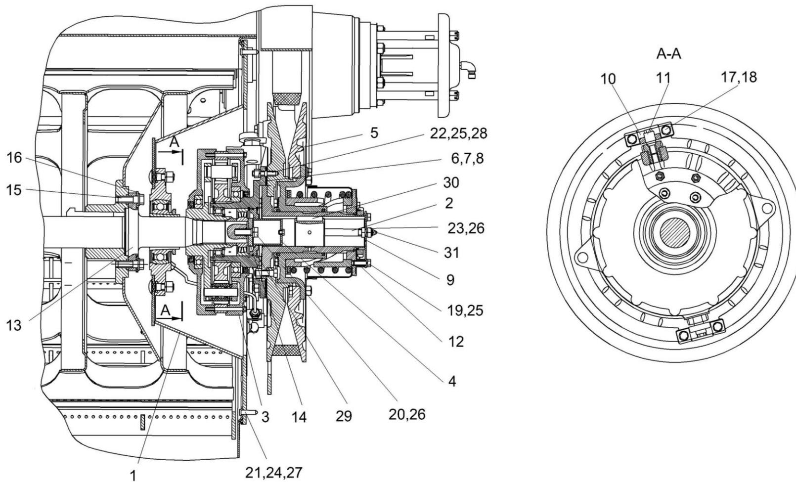
Рисунок 244 – Установка редуктора КЗК-12-0102700
