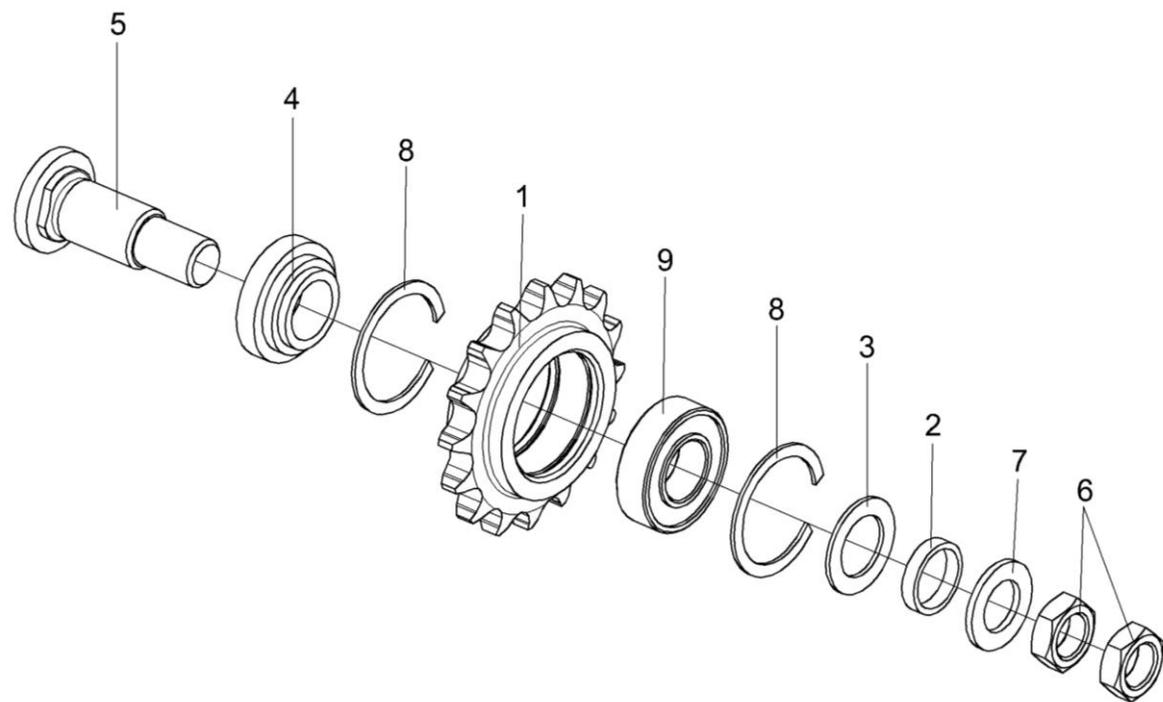
Рисунок 107 – Звездочка КЗР 0219070Б
