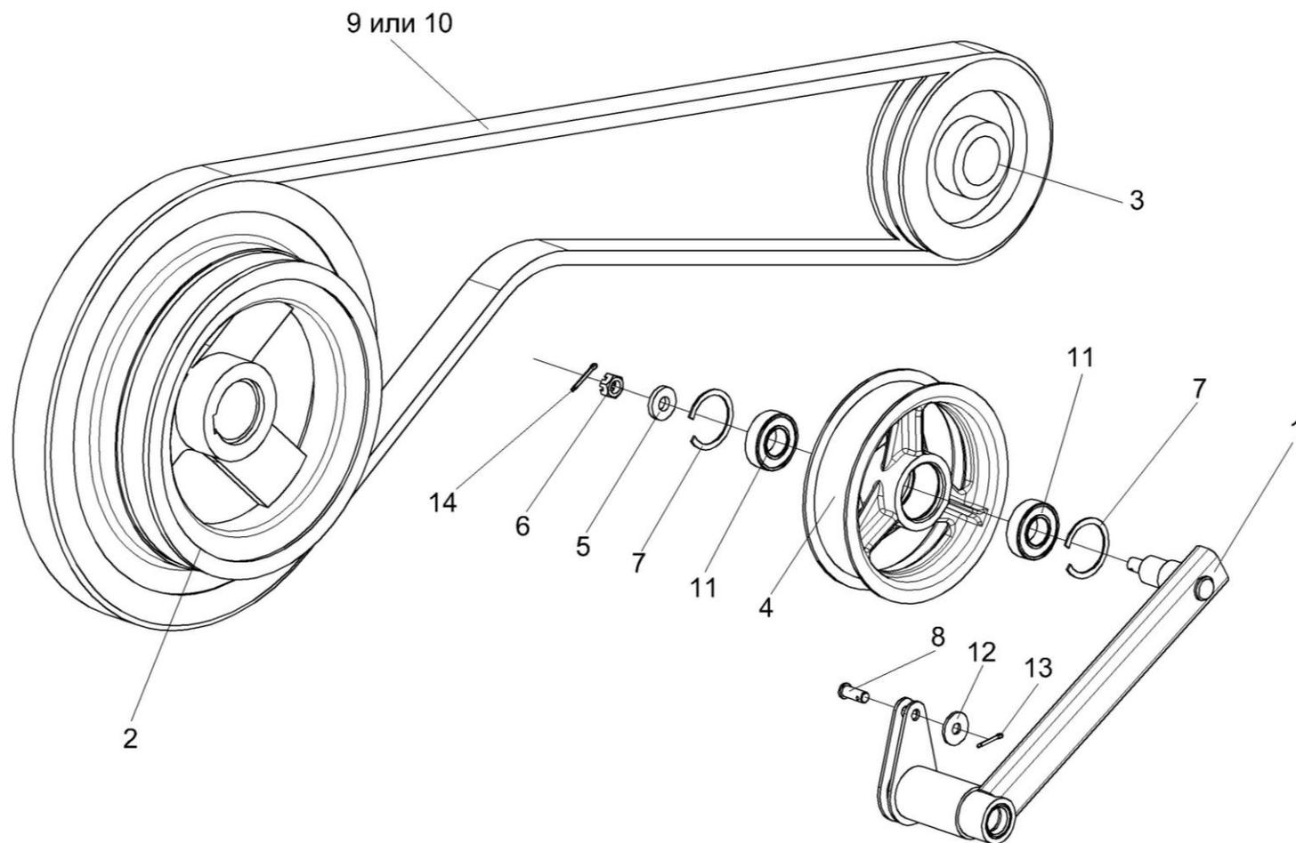
Рисунок 50 – Установка рычага КЗК 0202430В
