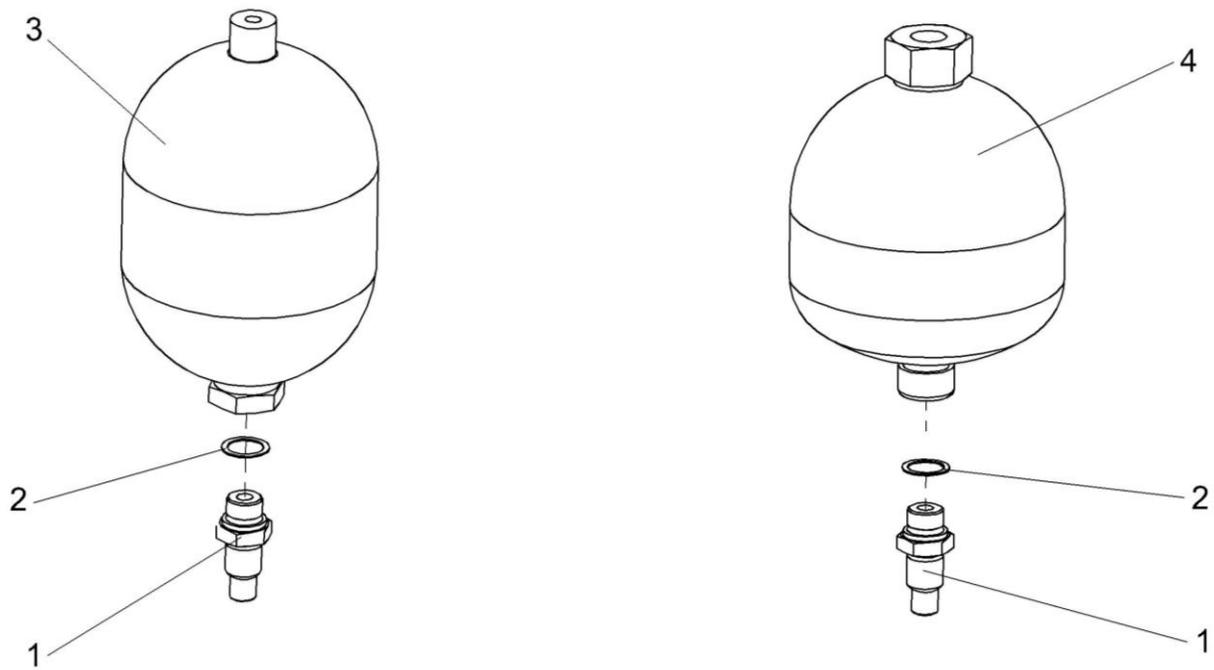
Рисунок 238 – Пневмогидроаккумуляторы УЭС-7-0602440-02 и УЭС-7-0602470
