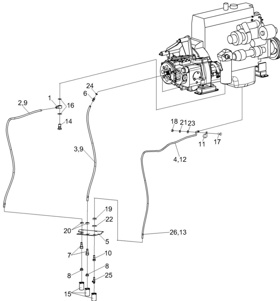
Рисунок 192 – Установка сливных рукавов КЗК-12-2-0106490
