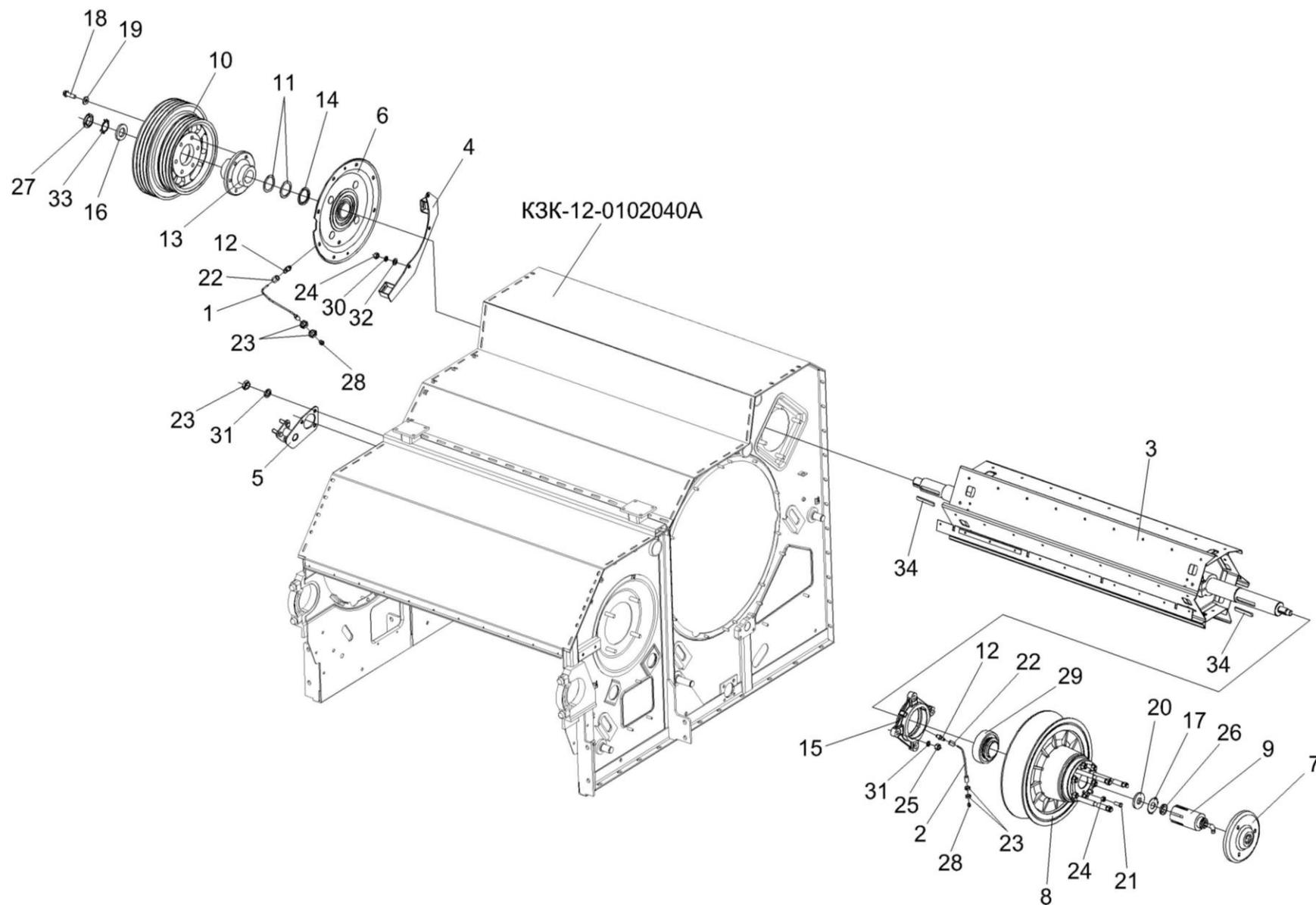
Рисунок 53 – Аппарат молотильный КЗК-12-1-0102000 (установка битера отбойного)
