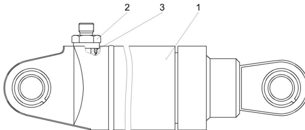
Рисунок 223 – Гидроцилиндр КЗК-12-060740
