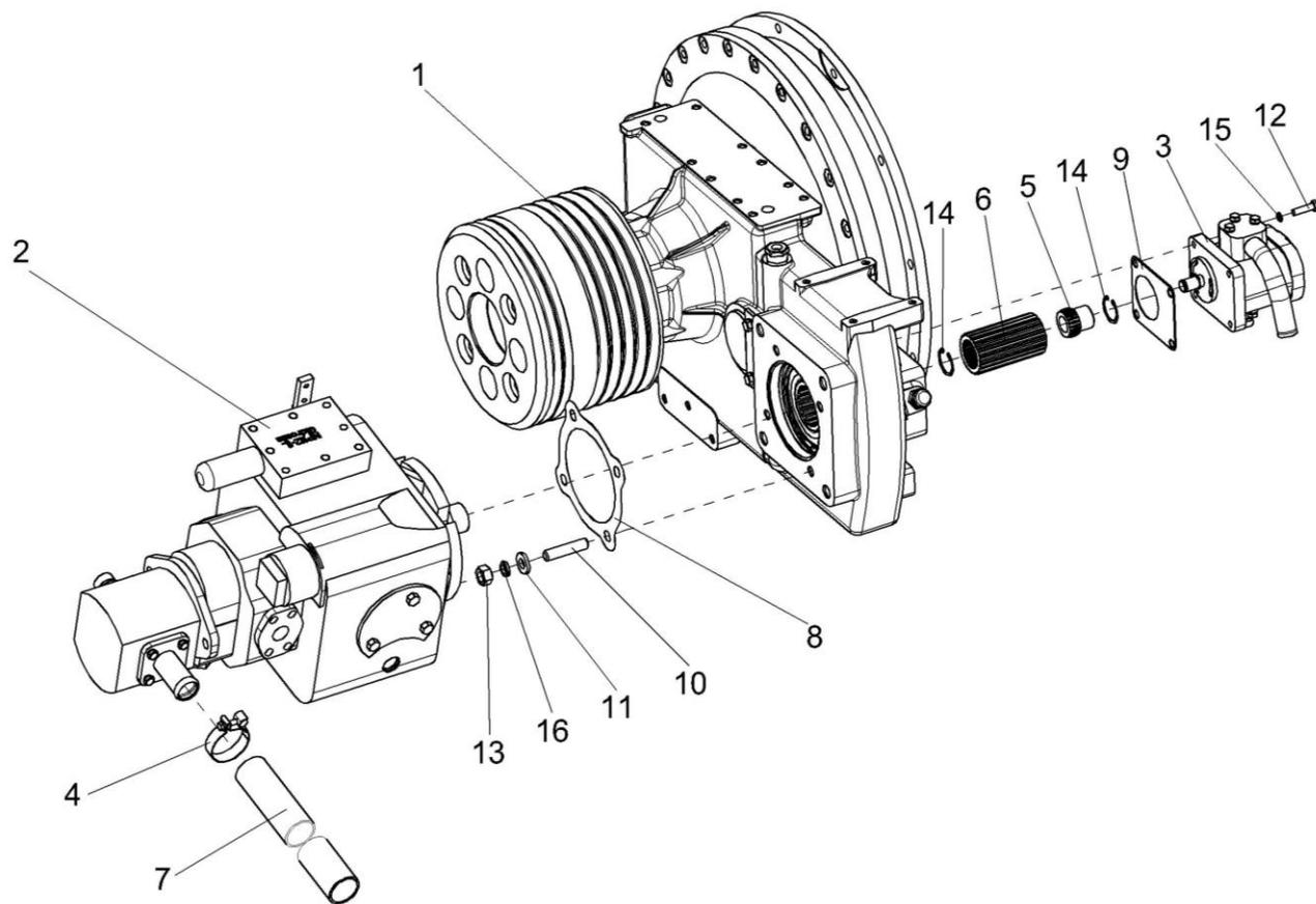
Рисунок 184 – Установка гидронасосов КЗК-12-3-0106750-01
