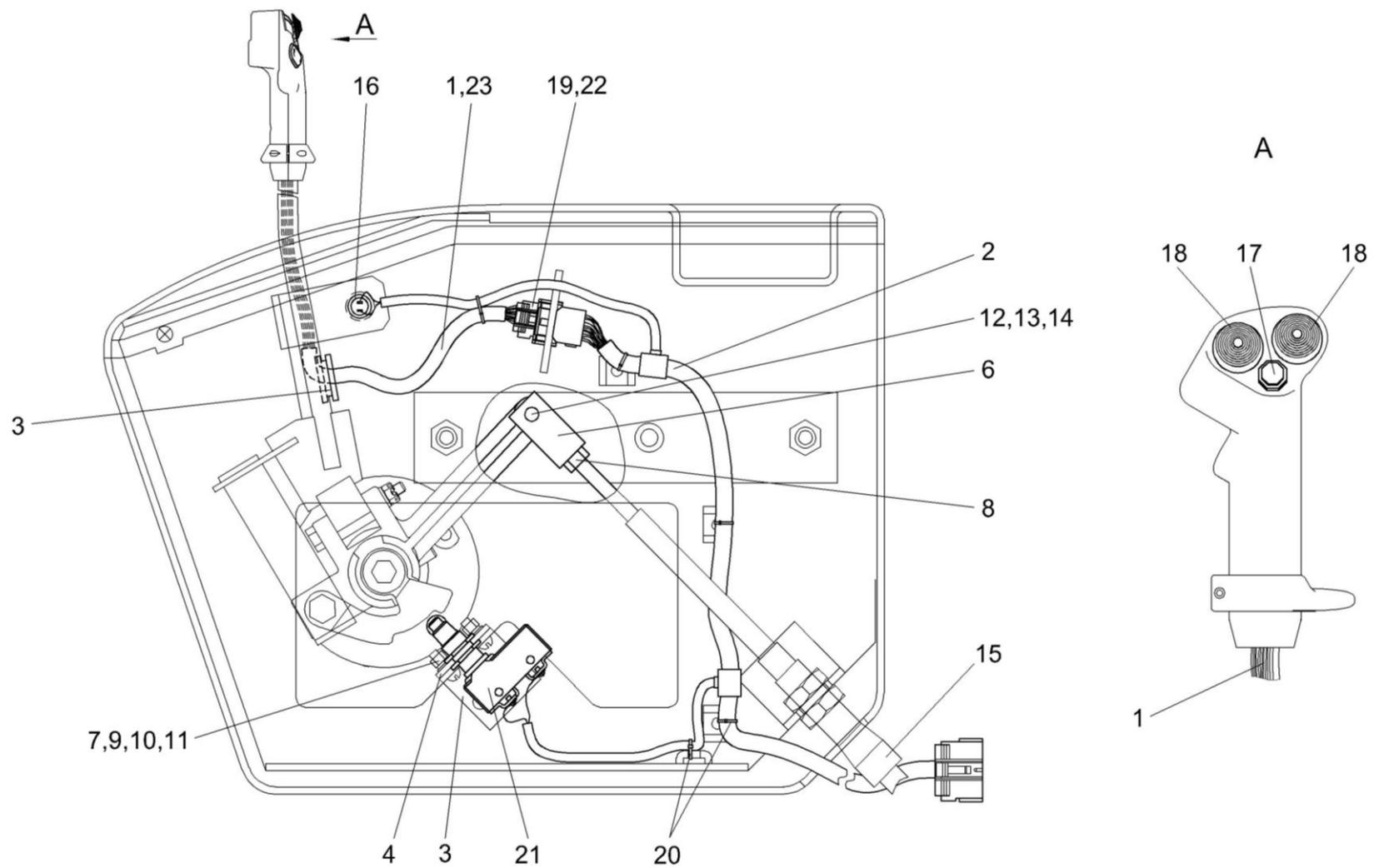
Рисунок 146 – Электрооборудование блока управления КЗК-12-0119890А-01
