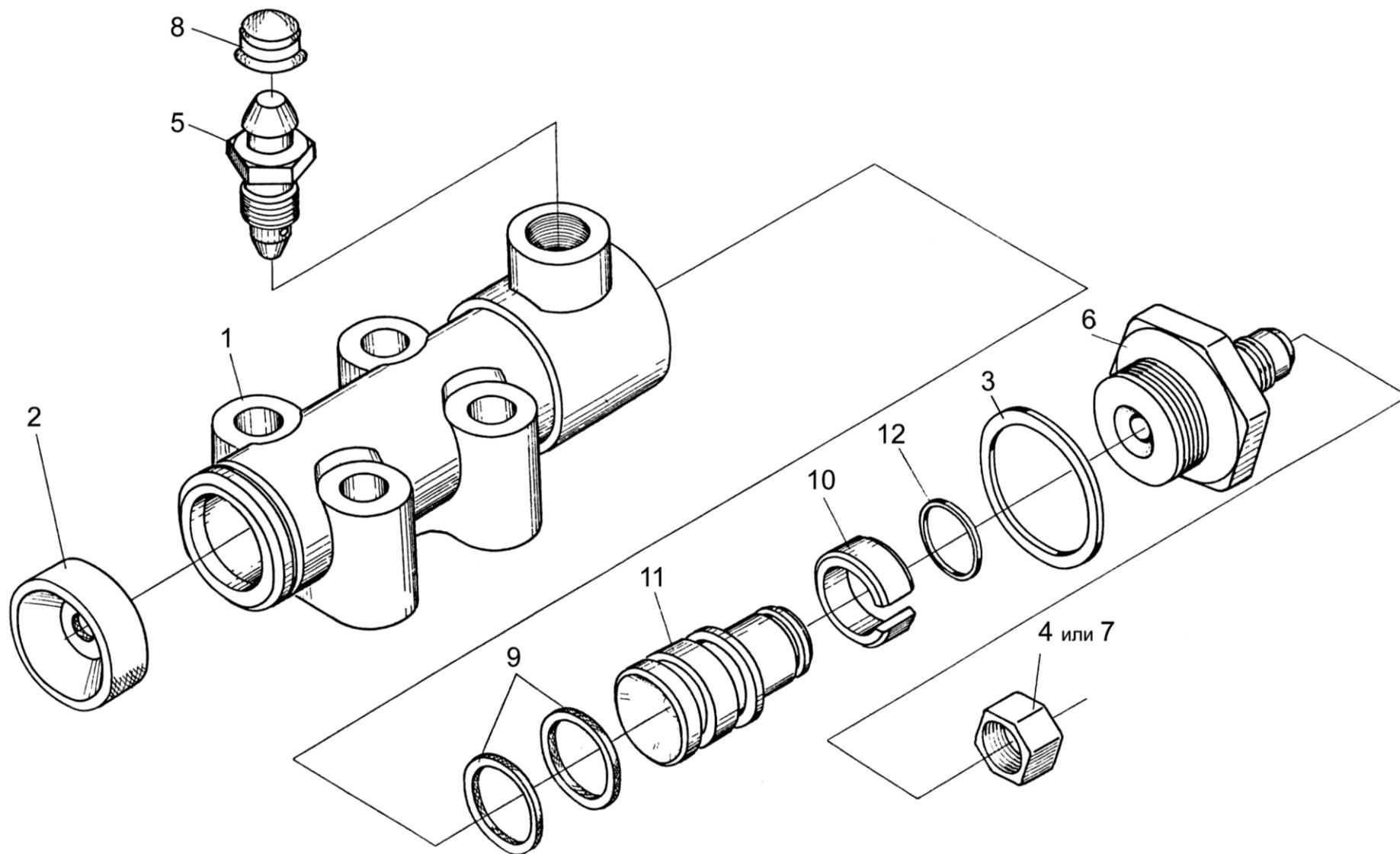
Рисунок 76 – Гидроцилиндр тормоза МК-23М.03.220А
