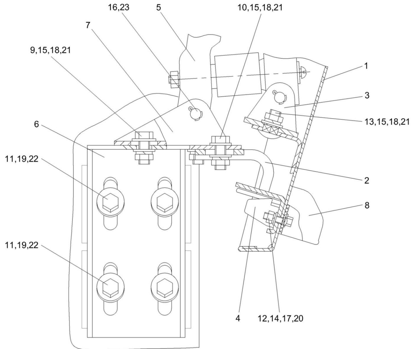
Рисунок 170 – Установка капота К3К-12-0128110
