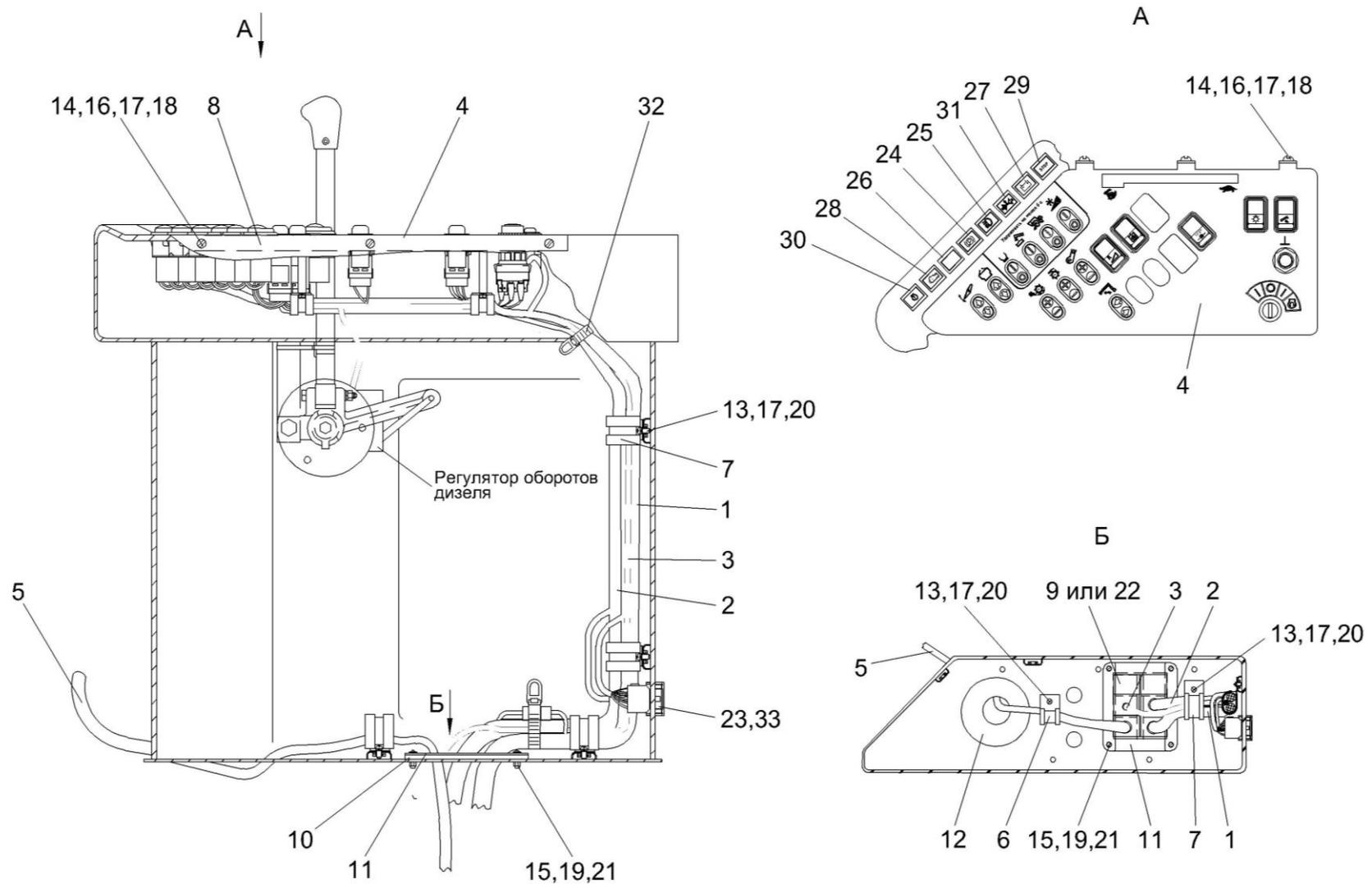
Рисунок 150 – Электрооборудование пульта управления КЗК-12-2-0119500
