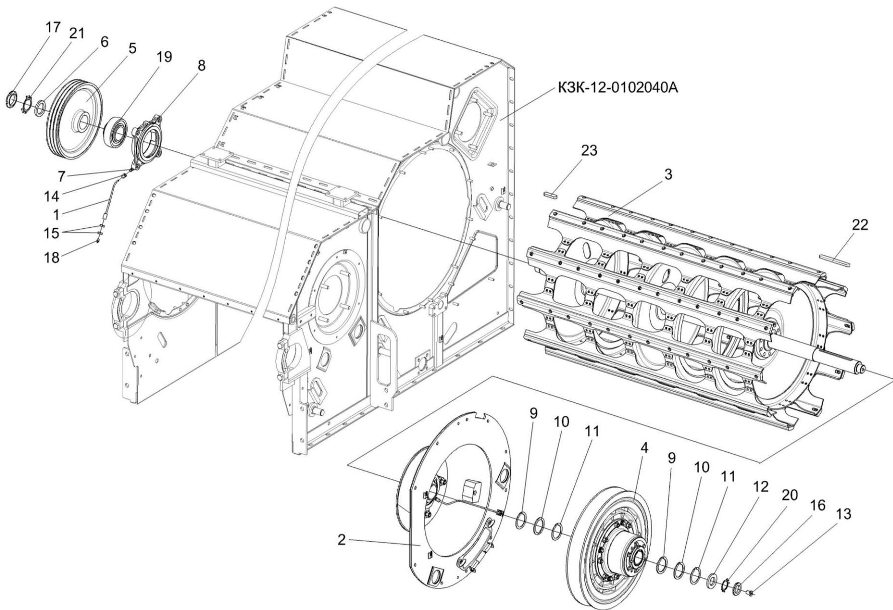
Рисунок 54 – Аппарат молотильный КЗК-12-1-0102000 (установка барабана молотильного)
