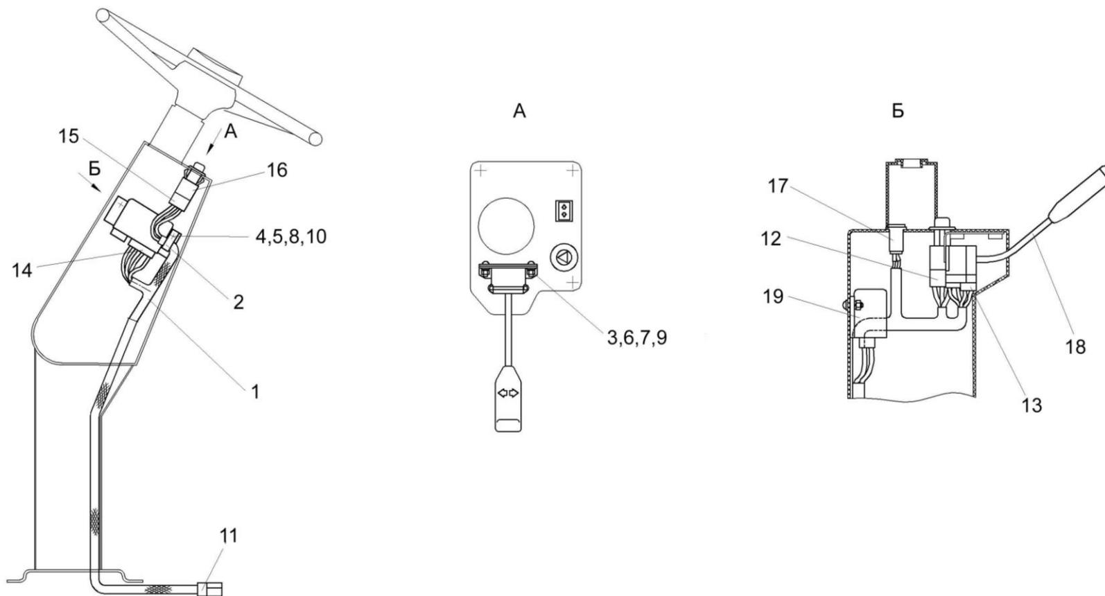
Рисунок 157 – Электрооборудование рулевой колонки КВС-1-0129230-01
