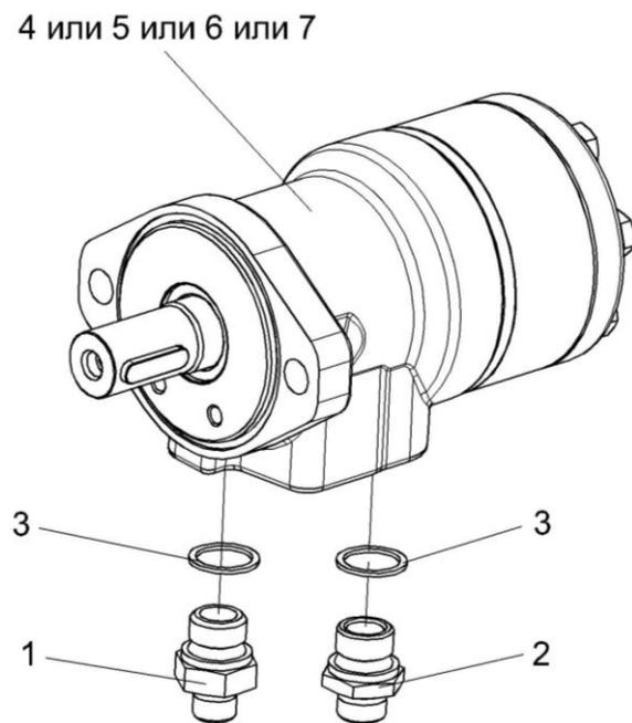
Рисунок 21 – Гидромотор КЗК-12-1790990А
