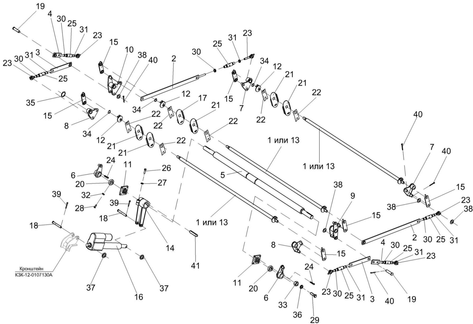
Рисунок 64 – Установка механизма подъема подбарабаний КЗК-12-0115000
