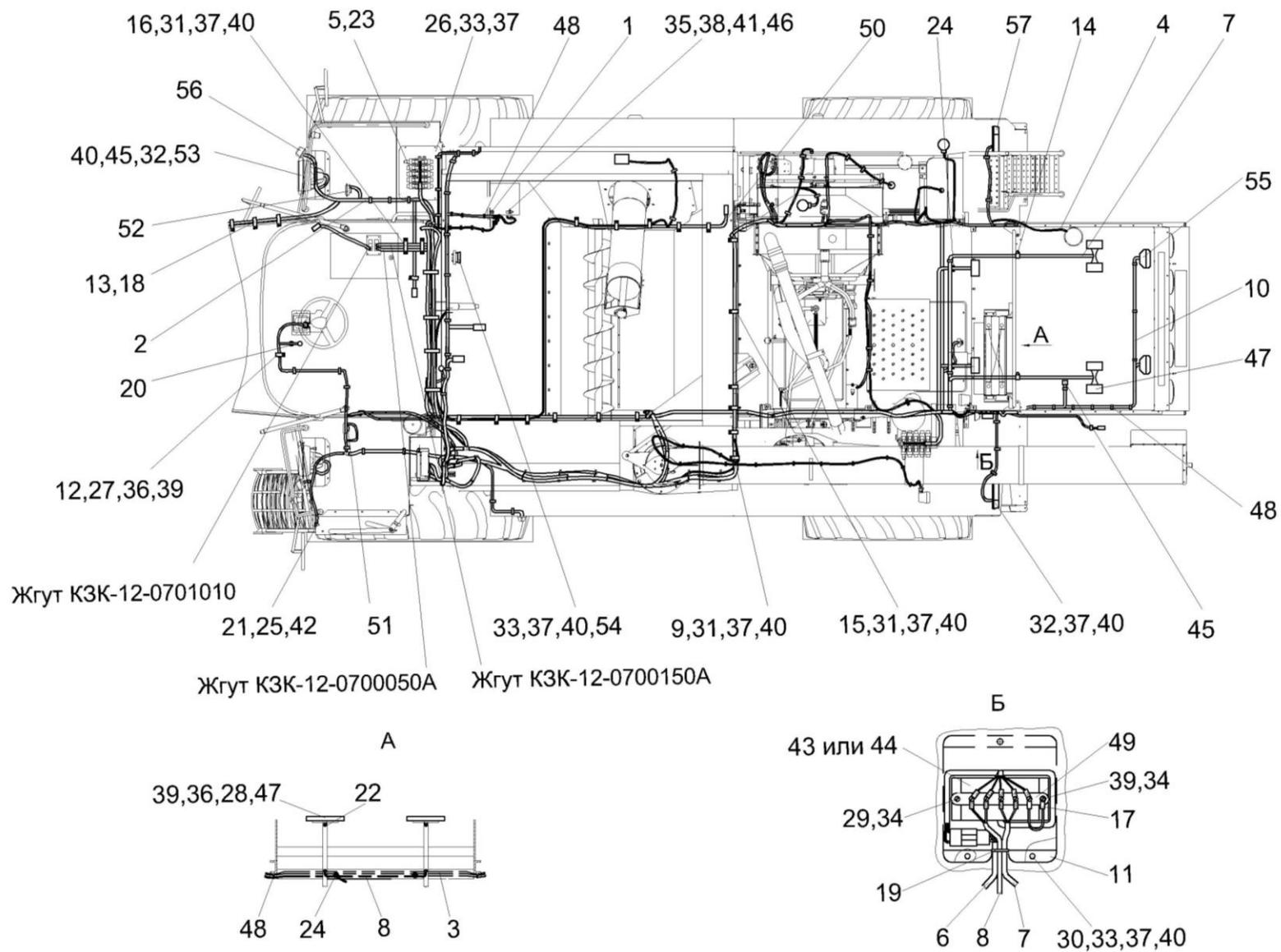
Рисунок 8 – Электрооборудование молотилки самоходной КЗК-12-010000Б-10 (лист 3)
