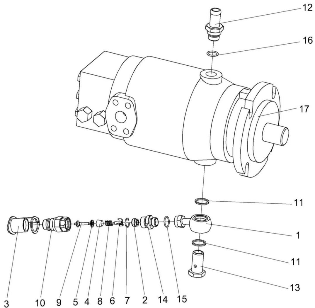
Рисунок 218 – Гидромотор КЗК-12-0601230
