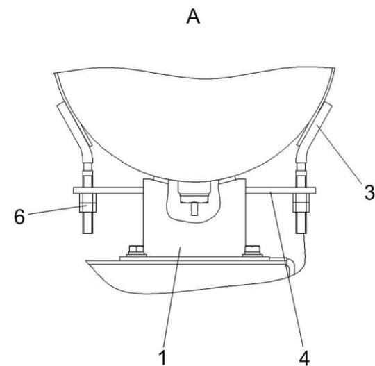
Рисунок 241 – Установка ресивера КЗК-12-0800010-01
