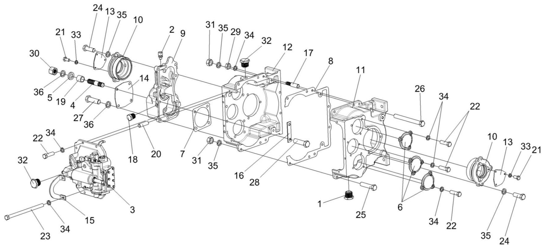
Рисунок 77 – Коробка диапазонов КЗК-12-0107310 (корпус, крышки)
