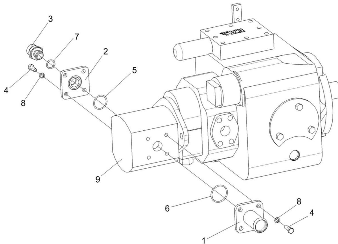
Рисунок 188 – Насос двухсекционный КЗК-12-0601400
