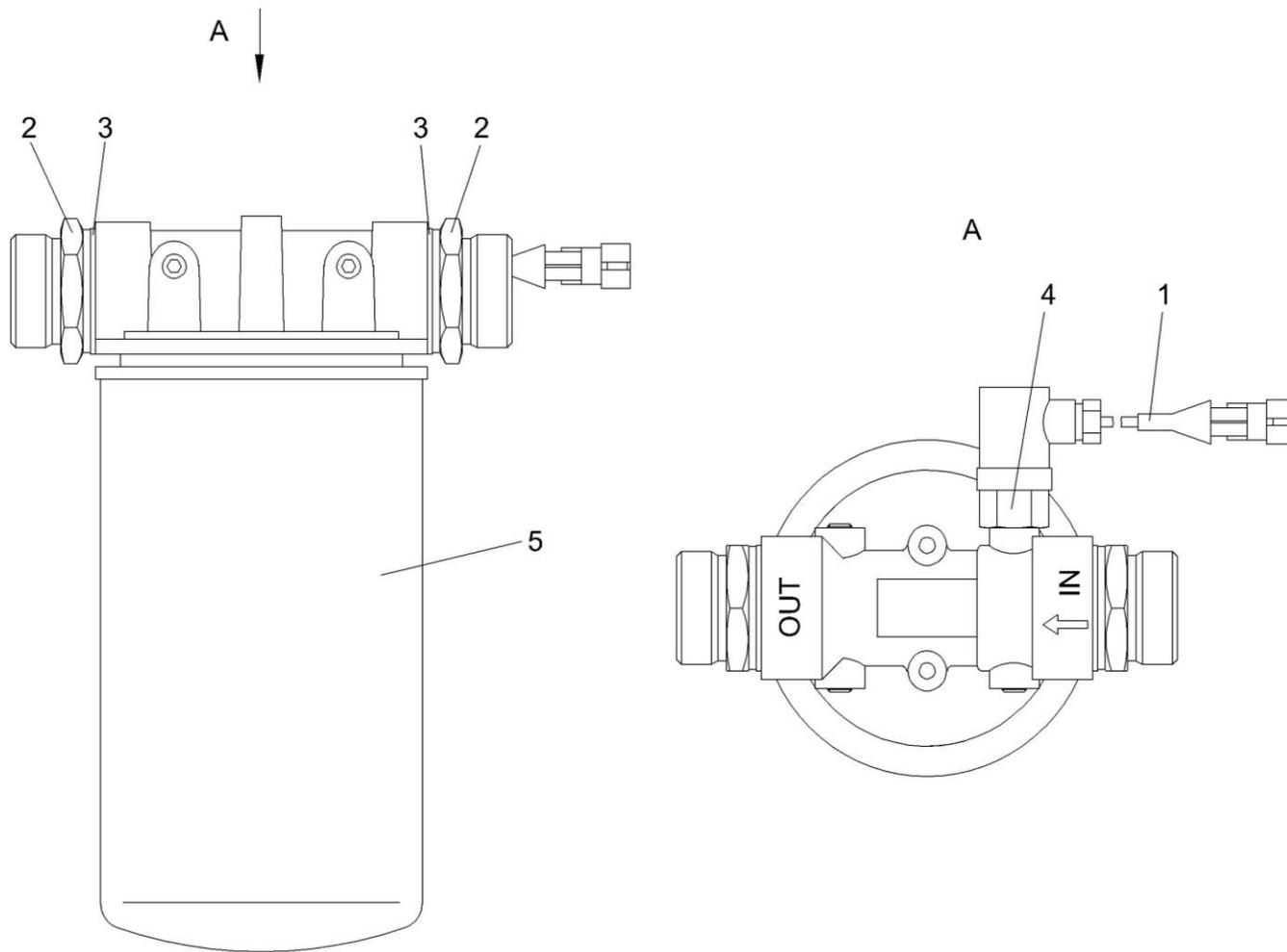
Рисунок 225 – Фильтр сливной КЗК-12-0602400
