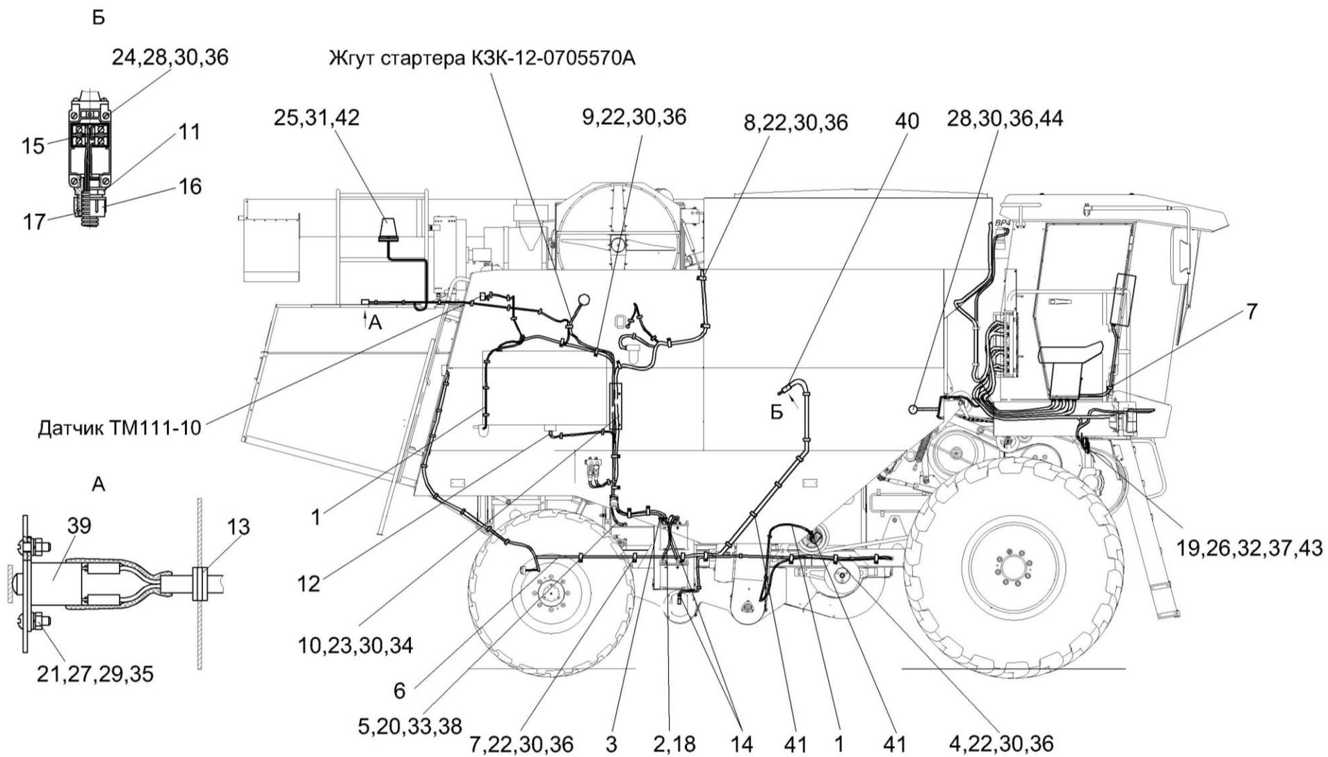
Рисунок 7 – Электрооборудование молотилки самоходной КЗК-12-0100000Б-10 (лист 2)
