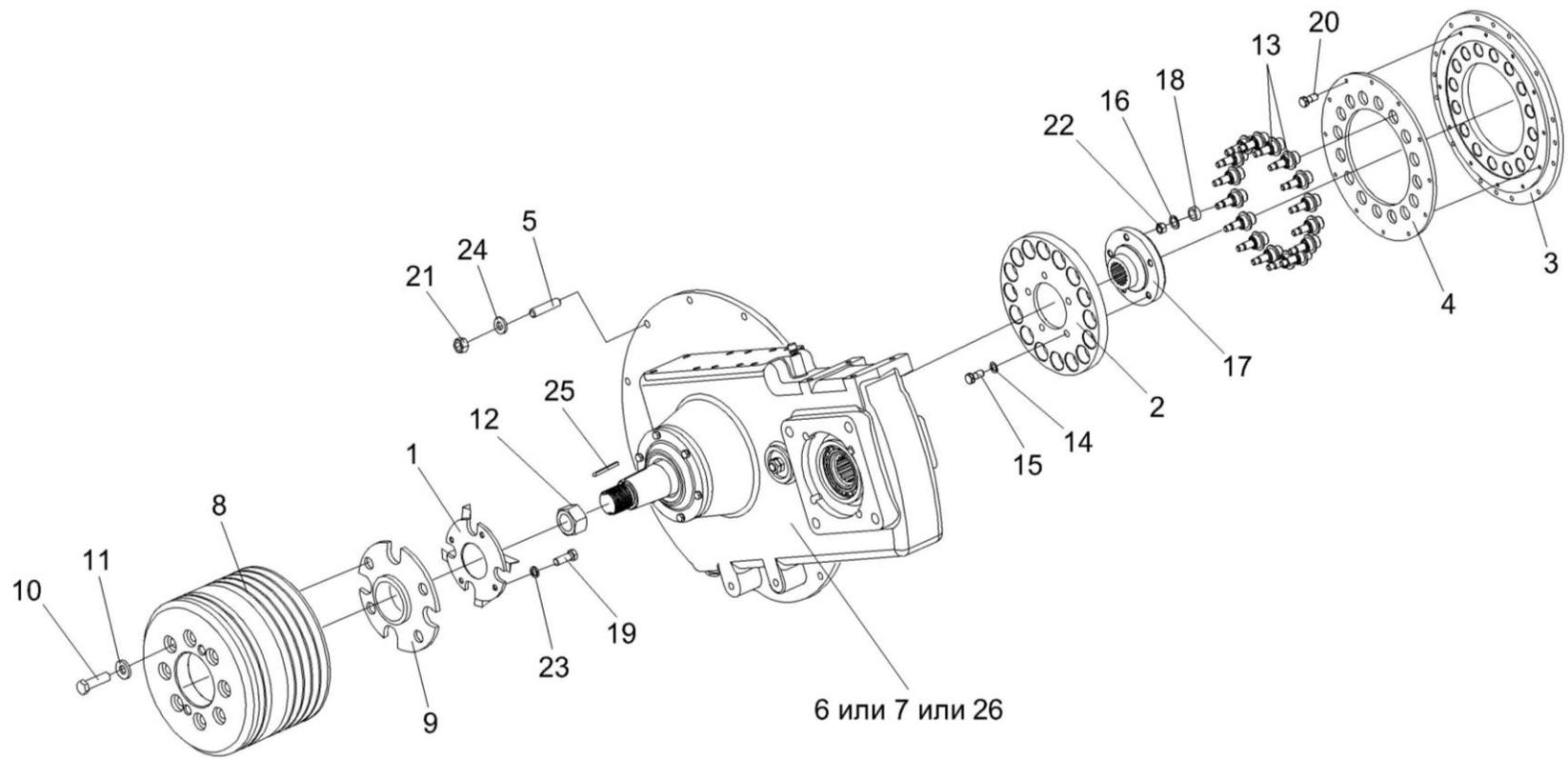
Рисунок 185 – Установка главного привода
