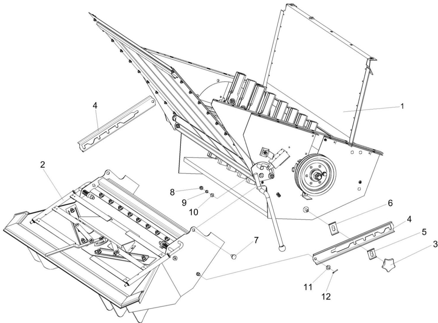
Рисунок 122 – Соломоизмельчитель КЗК-12-0290600. Установка дефлектора КЗК-12-0290320
