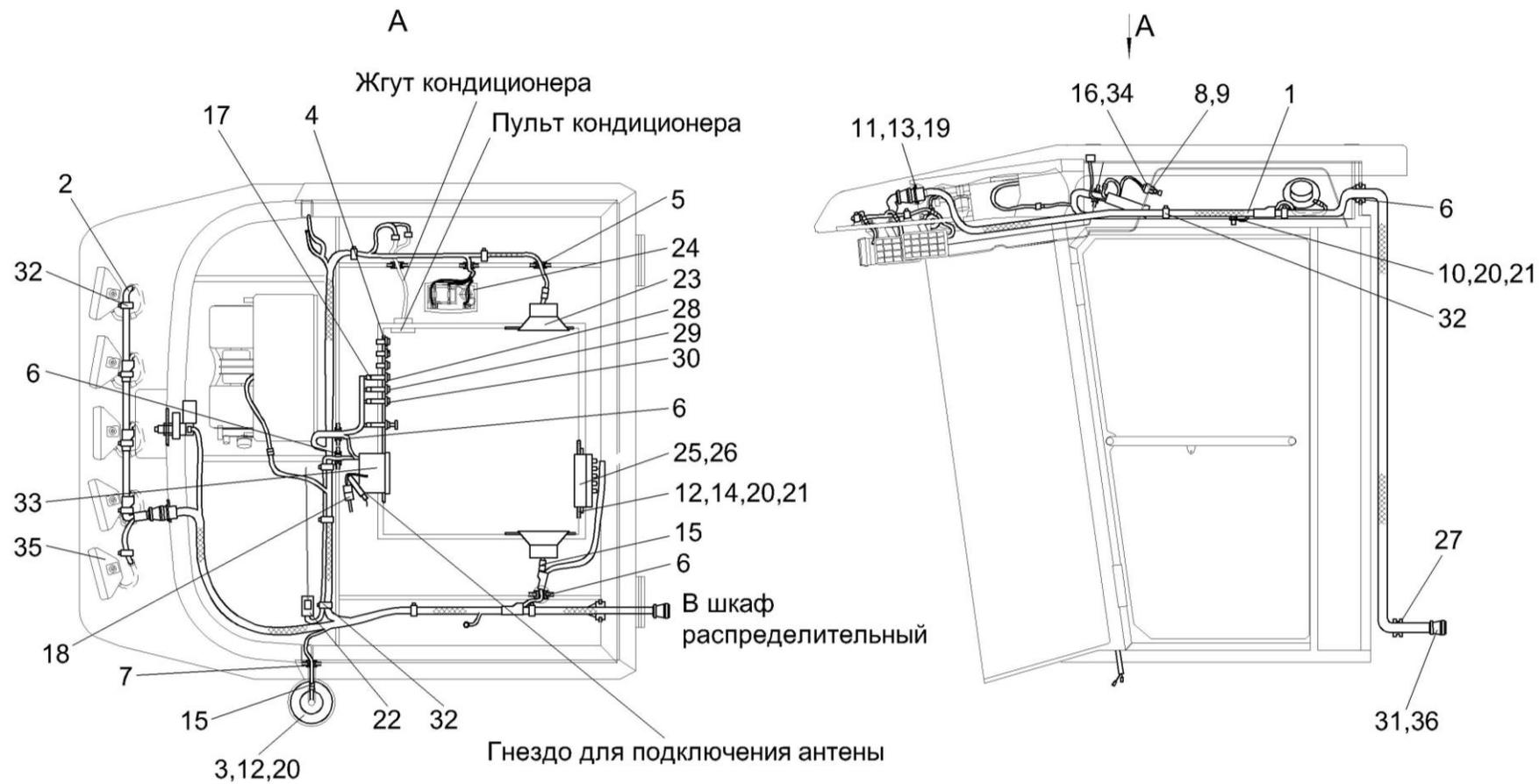
Рисунок 136 – Электрооборудование кабины КЗК-12-0120000
