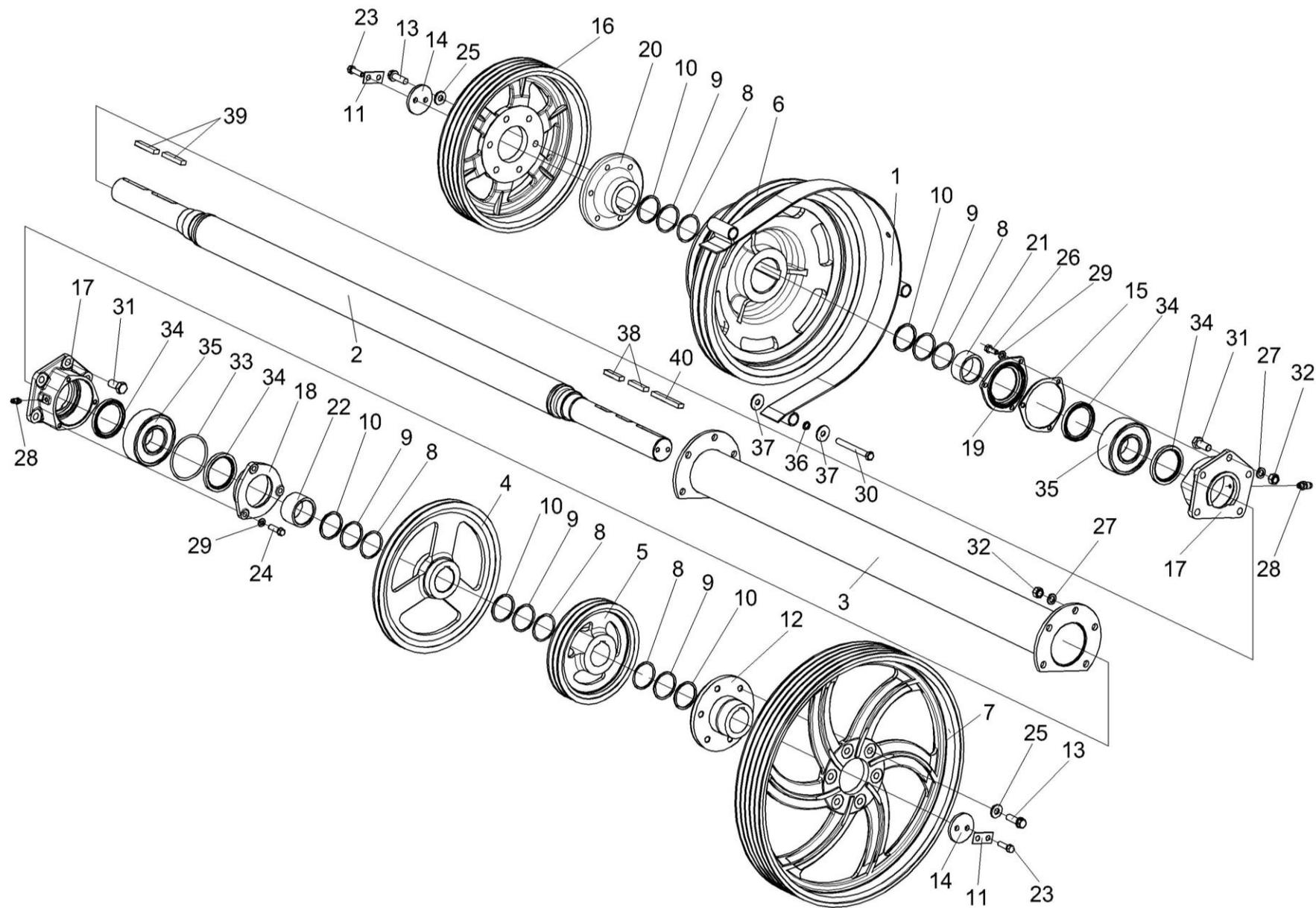
Рисунок 34 – Установка шкивов КЗК-12-0202860А и КЗК-10-0202010
