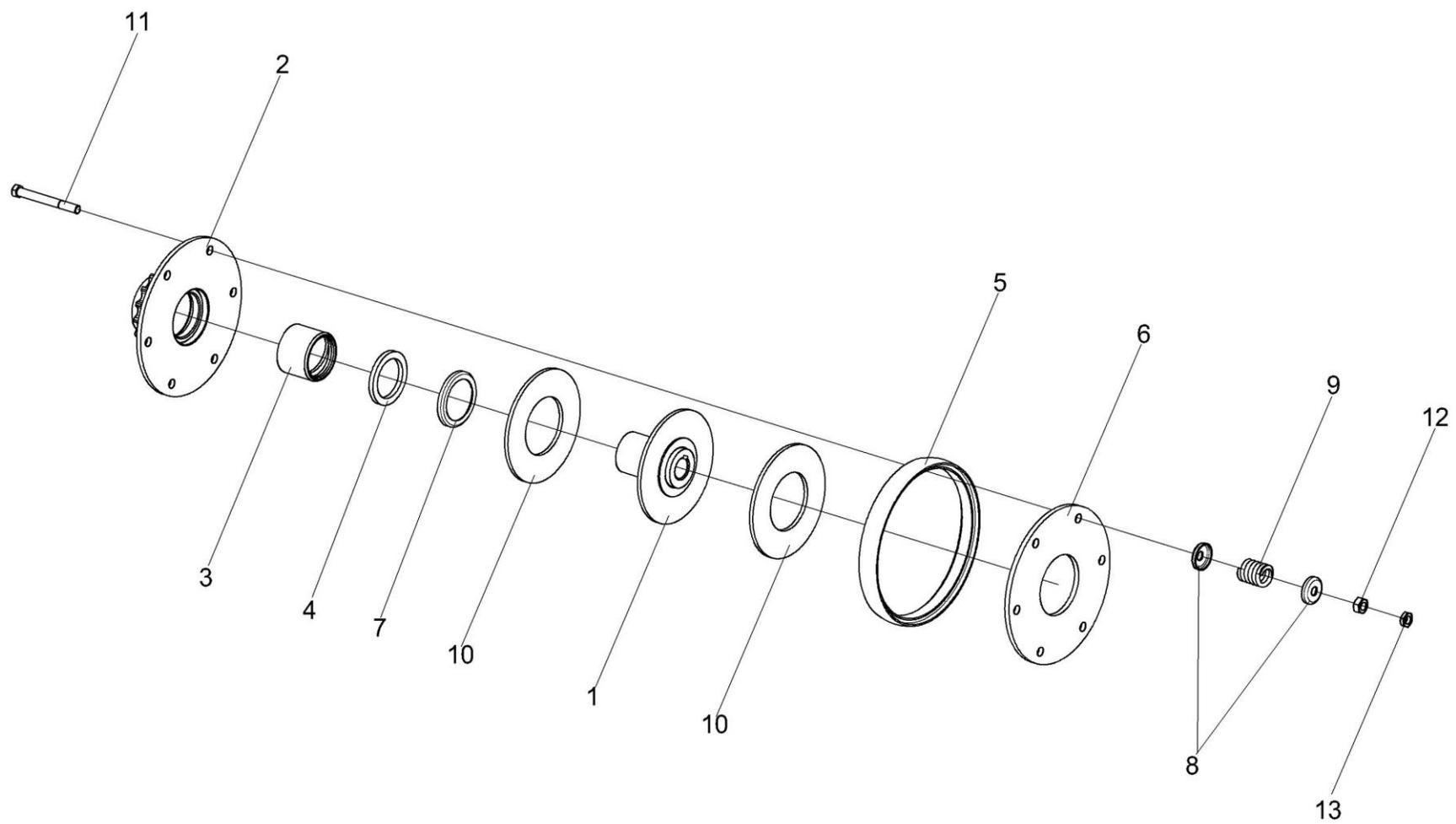
Рисунок 37 – Муфта фрикционная КЗК 0219020Б-01
