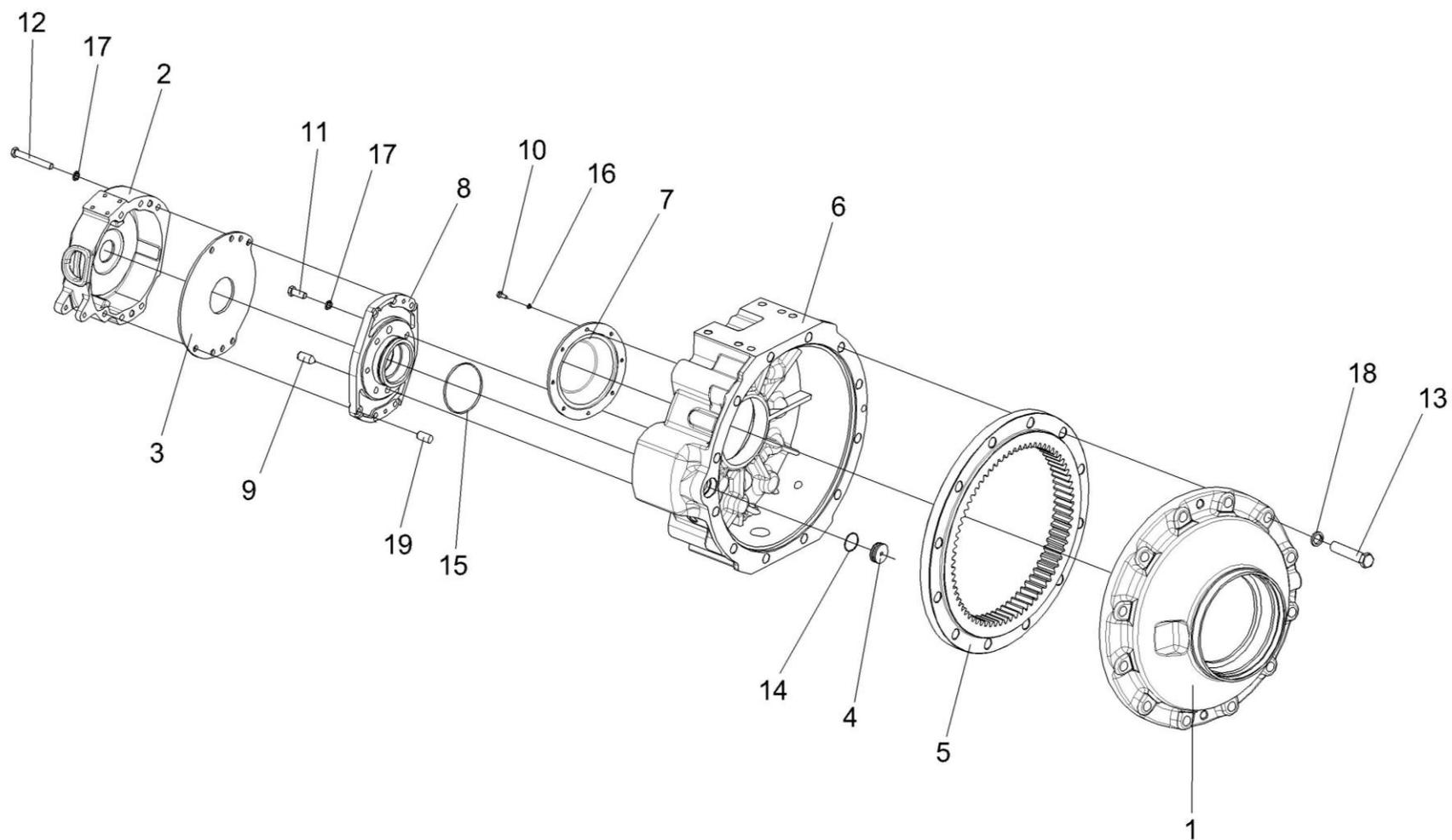
Рисунок 73 – Редуктор бортовой КЗК-10-0107200-04. Корпуса и крышки
