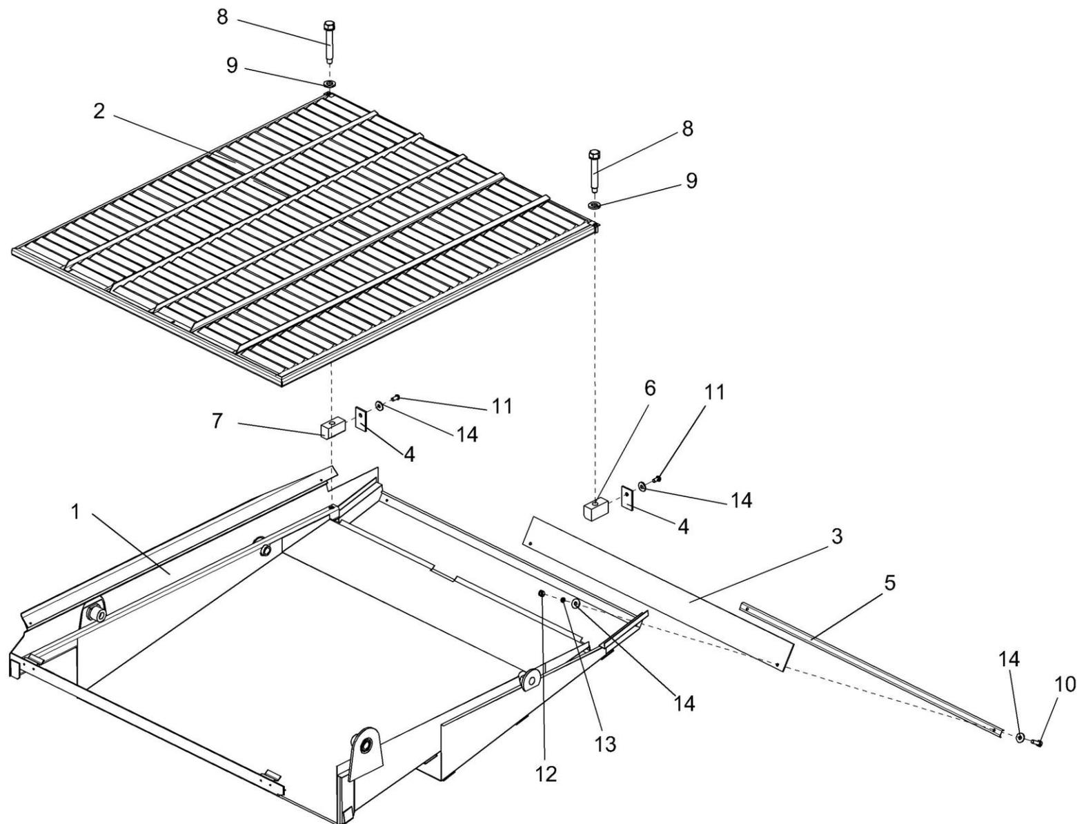
Рисунок 90 – Установка рамы стана решетного и решета
