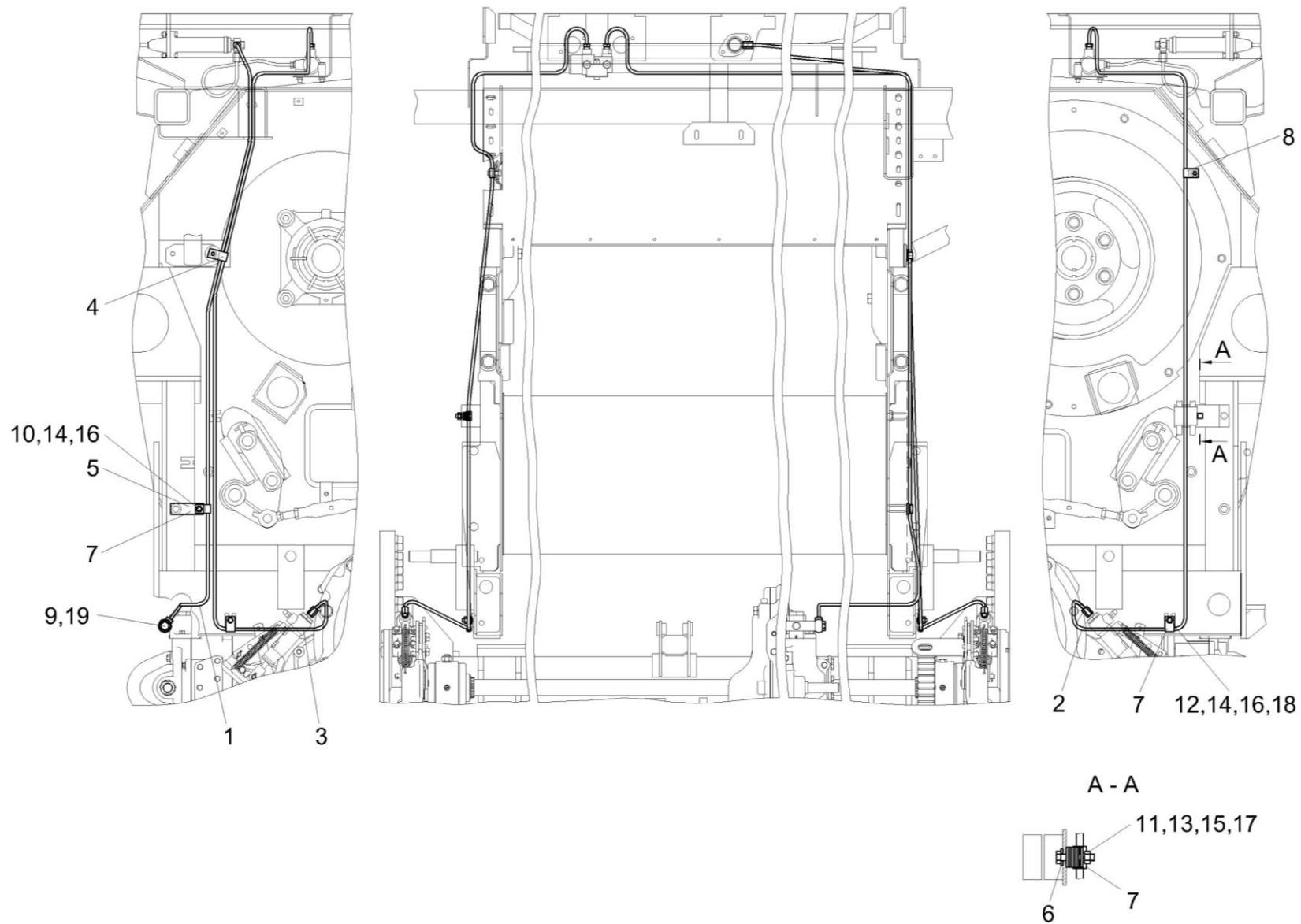
Рисунок 164 – Установка трубопроводов моста ведущих колес КЗК-12-0119630
