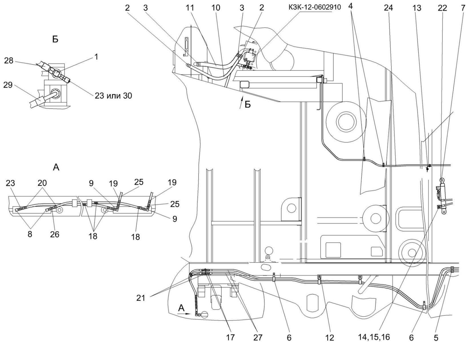
Рисунок 219 – Гидросистема рабочих органов и рулевого управления КЗК-12-0602000Б (вид справа) (лист 1)
