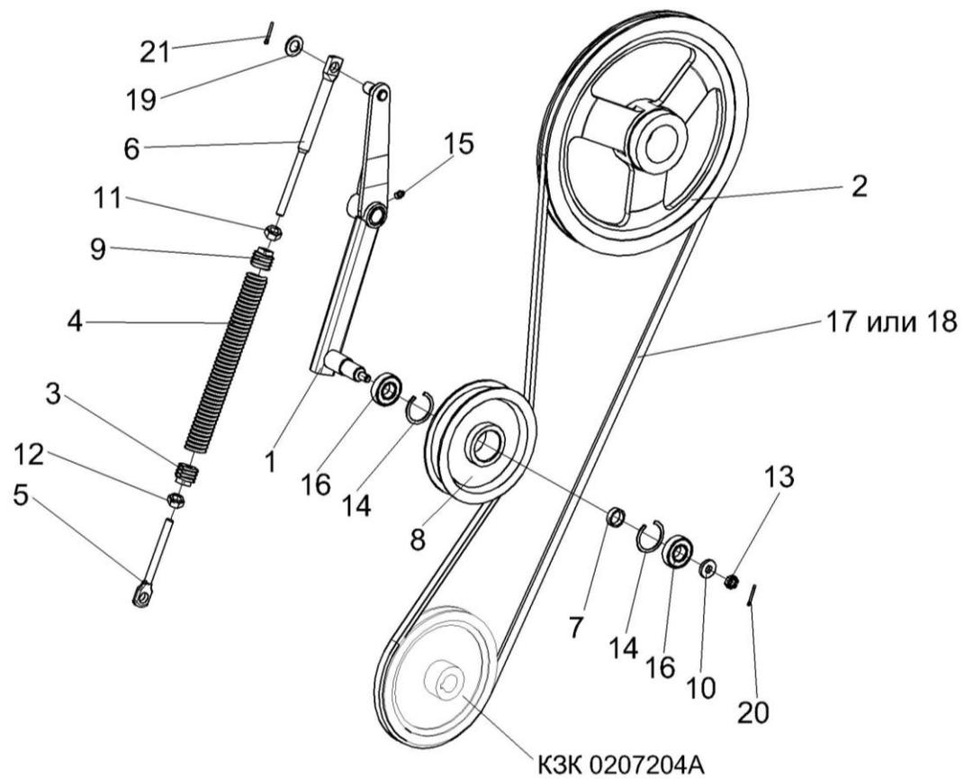
Рисунок 51 – Установка привода устройства домолачивающего
