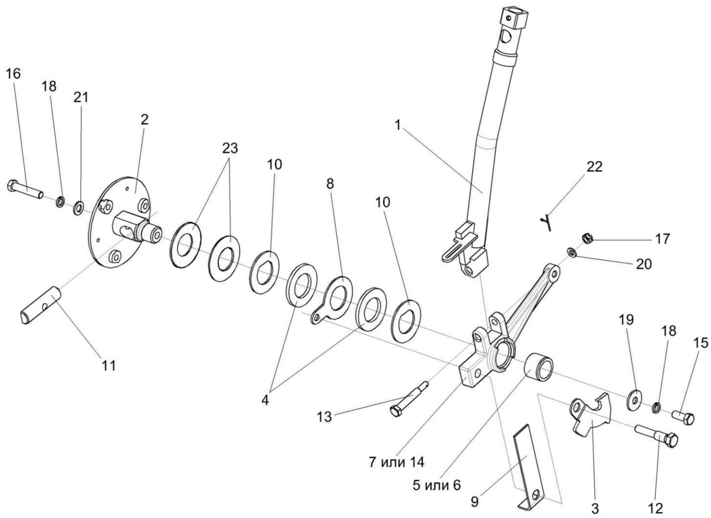
Рисунок 145 – Рычаг КЗК-12-0119920А
