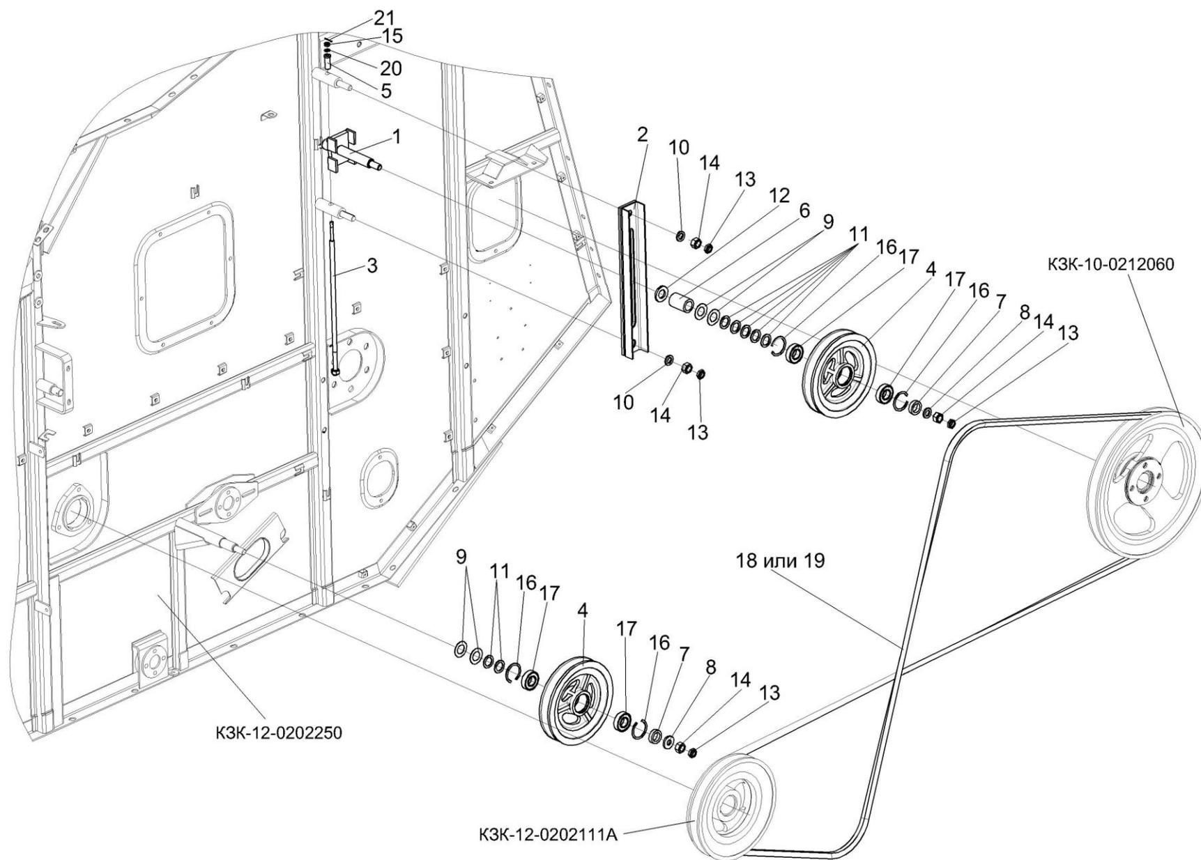
Рисунок 39 – Установка привода соломотряса
