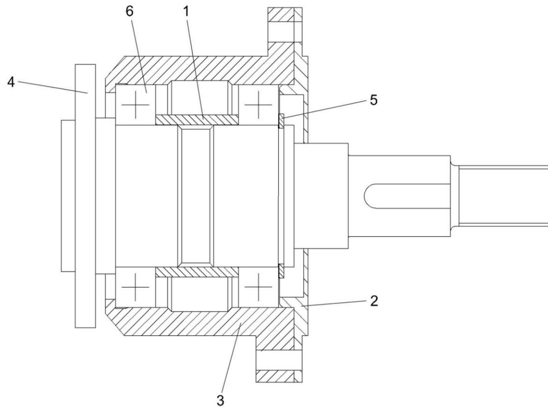
Рисунок 196 – Привод вентилятора КЗК-12-2-0106530
