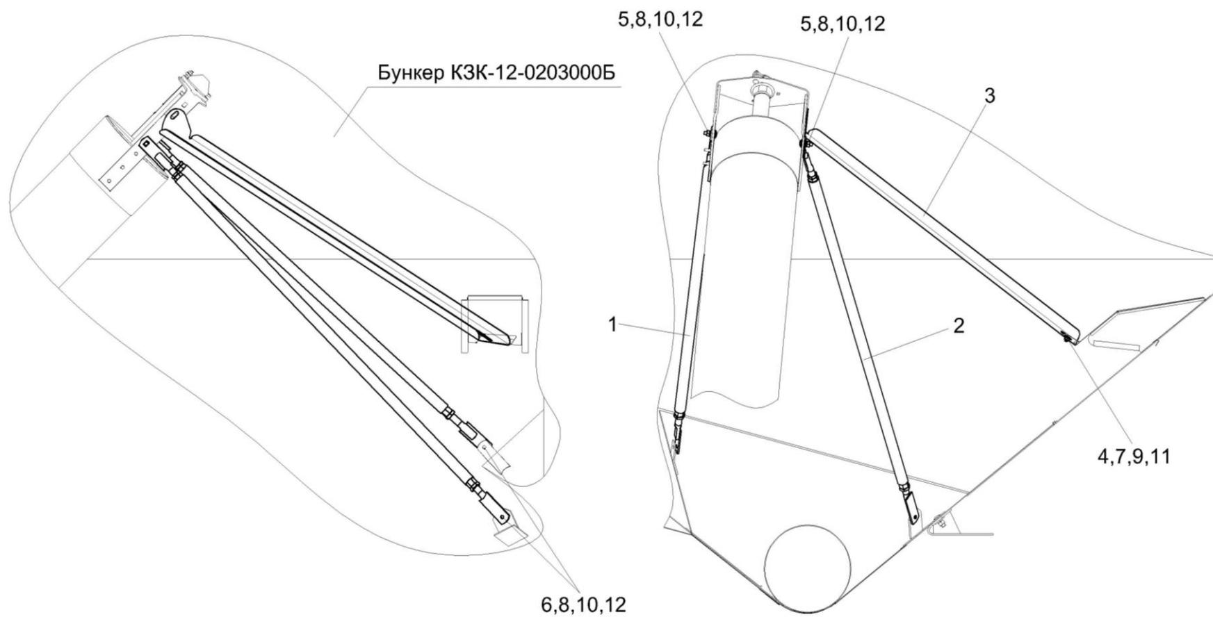
Рисунок 177 – Установка пробоотборника и раскосов КЗК-12-0203600
