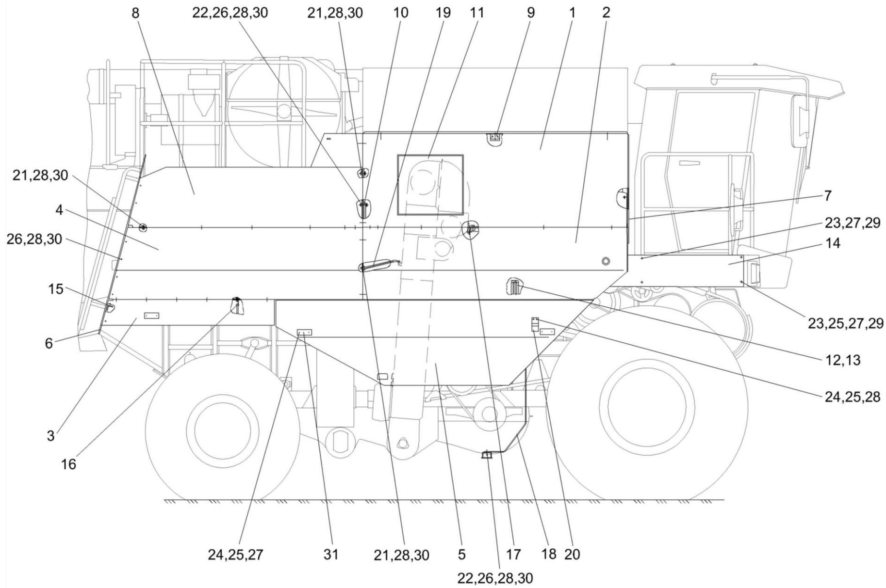
Рисунок 169 – Установка капотов и ограждения КЗК-12-0128000А (вид справа)
