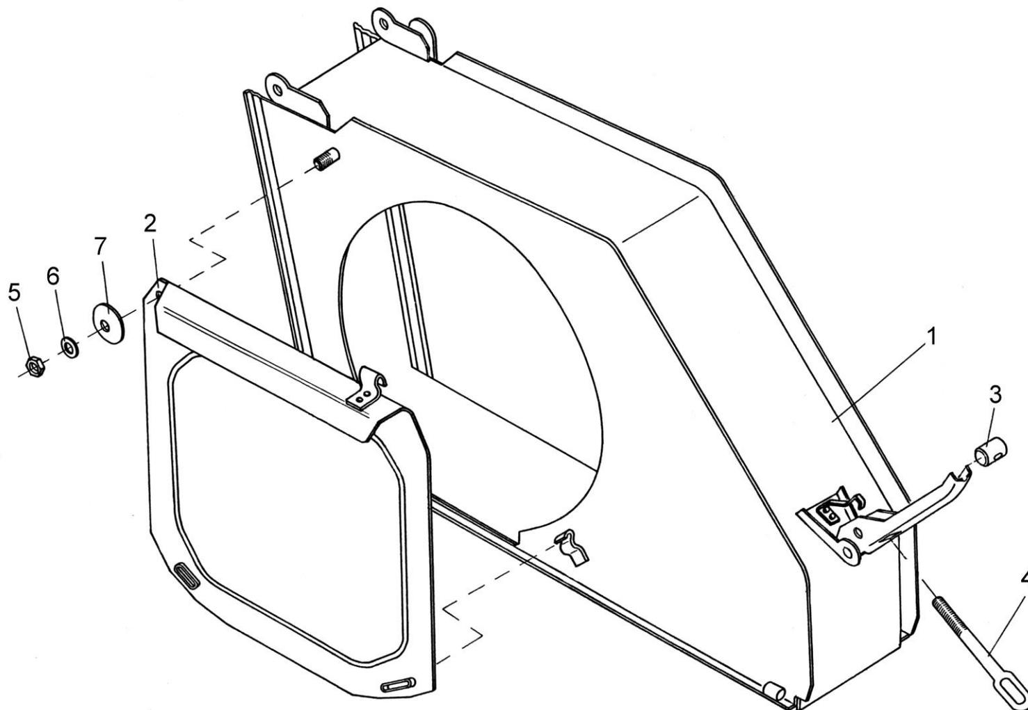
Рисунок 25 – Кожух верхний измельчителя ПКК 0103000А
