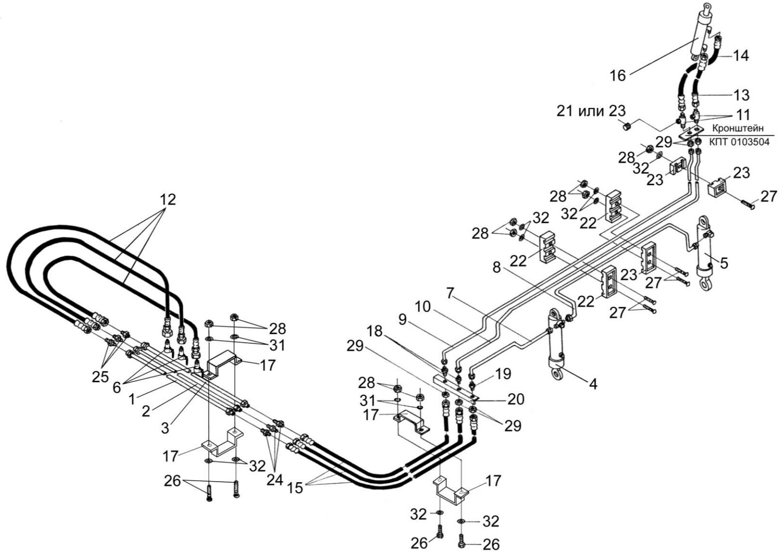
Рисунок 17 – Гидросистема прицепного шасси КПТ 0801000А
