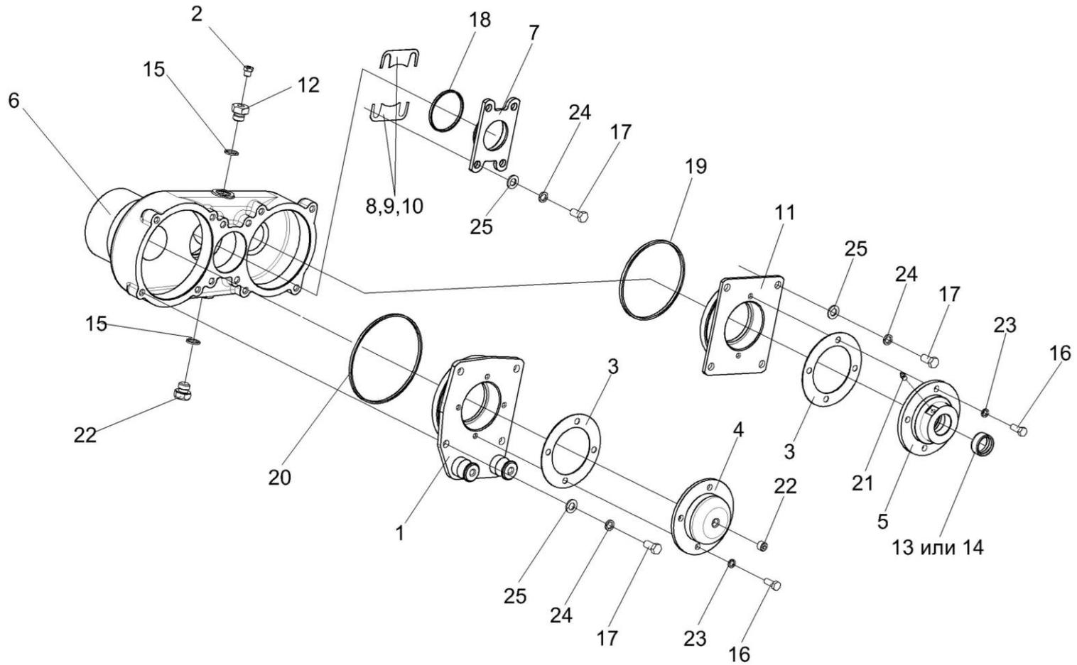
Рисунок 43 – Редуктор цилиндрический подпрессовывающих вальцев ПКК 0118000Б-01 (лист 1)
