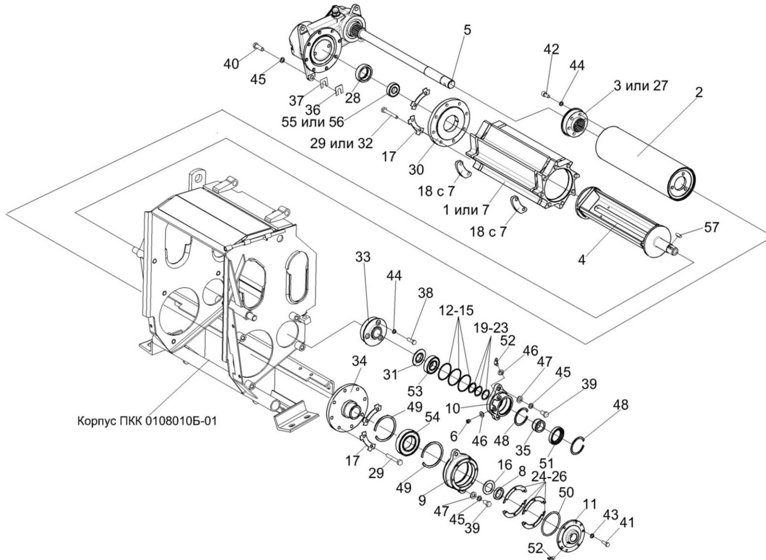
Рисунок 39 – Аппарат питающий ПКК 0108000Б (установка редуктора нижних валцов ПКК 0117000А-01)
