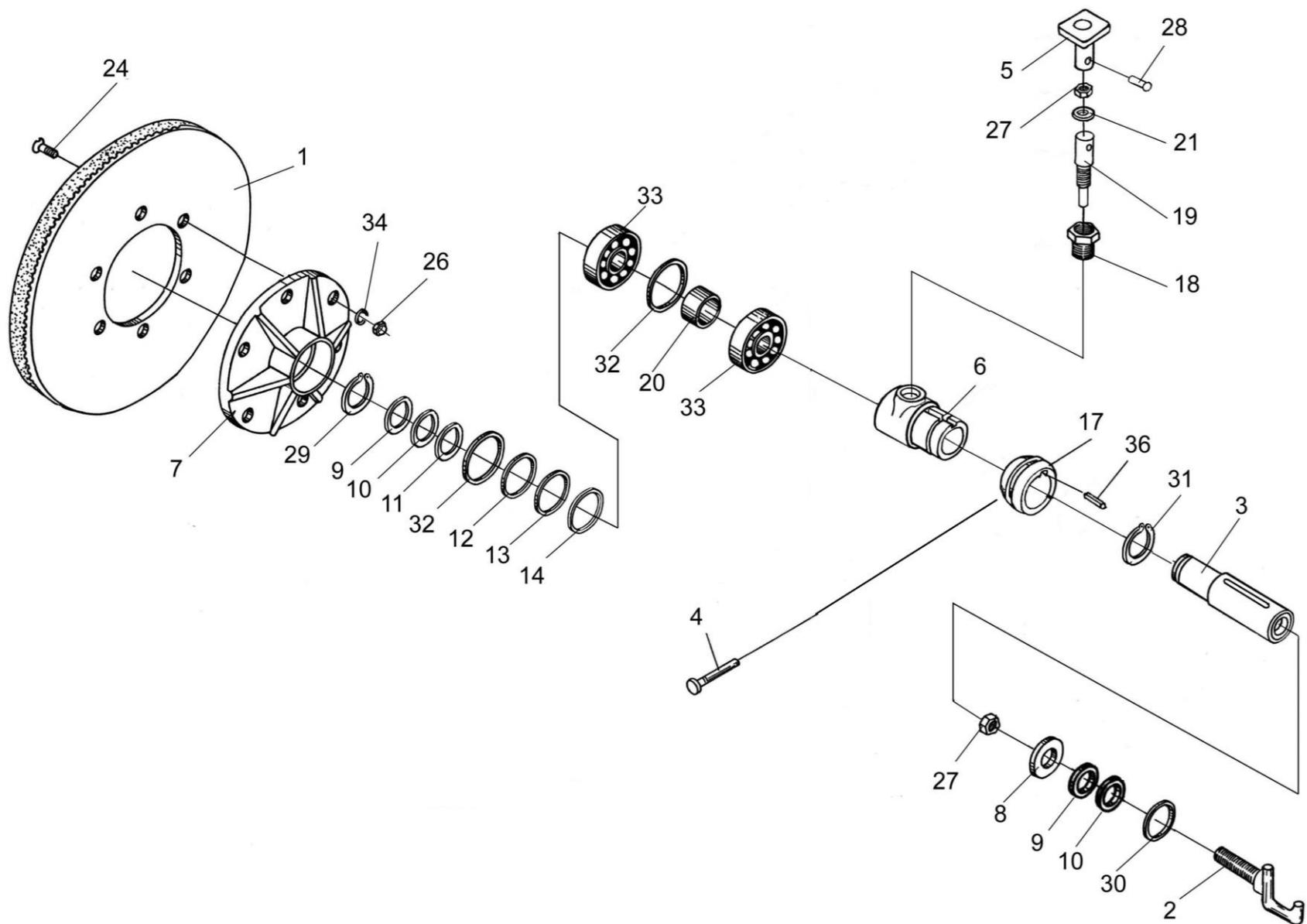
Рисунок 50 – Устройство заточное ПКК 0107000Б
