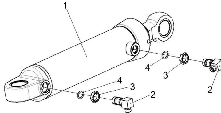
Рисунок 18 – Гидроцилиндр ПКК 0113200-03
