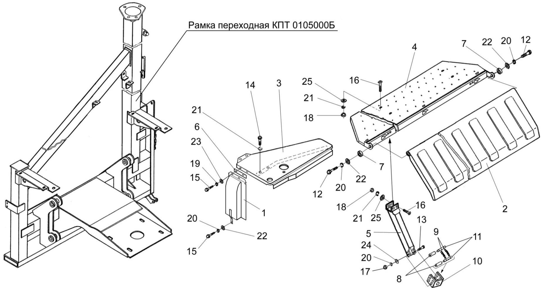
Рисунок 6 – Настил, ограждения, опоры
