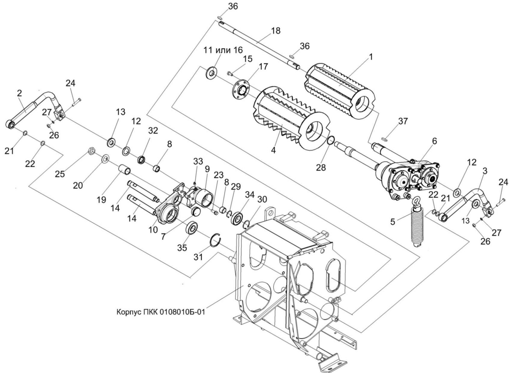
Рисунок 40 – Аппарат питающий ПКК 0108000Б (установка редуктора ПКК 0118000Б-01)
