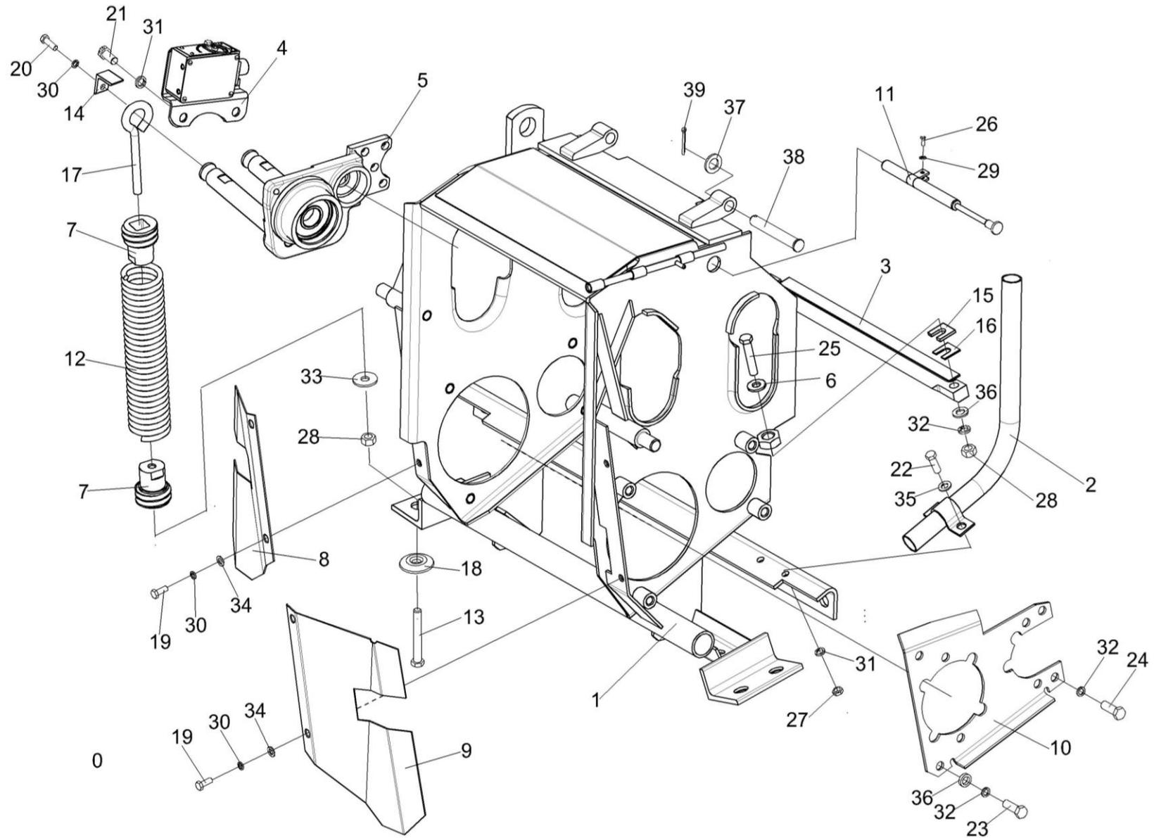
Рисунок 38 – Аппарат питающий ПКК 0108000Б (корпус, щитки, пружины)
