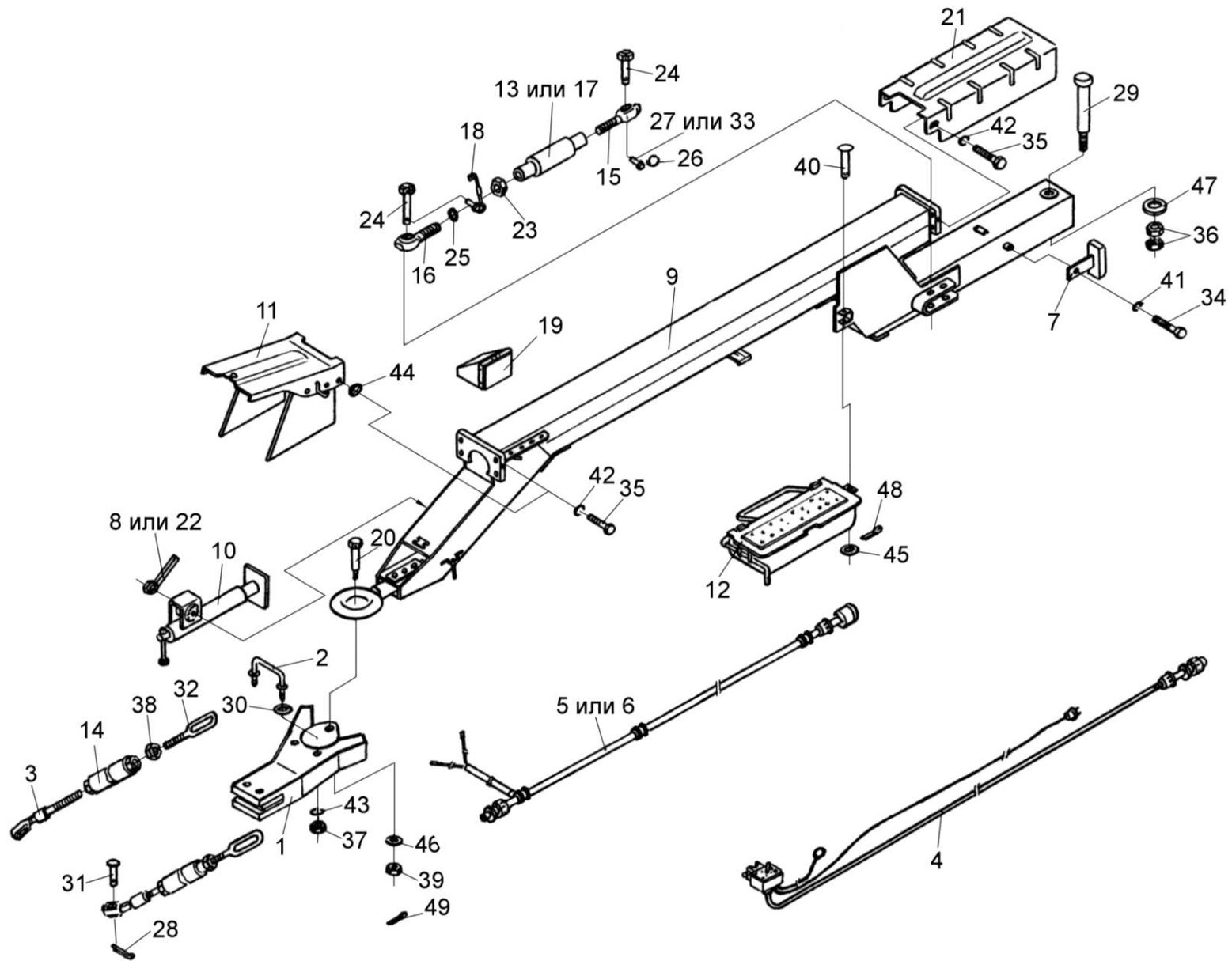
Рисунок 8 – Установка сннца КПТ 0300000В
