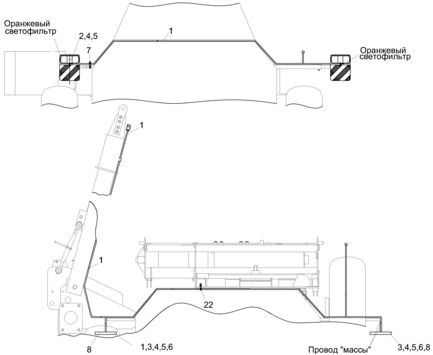
Рисунок 20 – Установка электрооборудования светосигнального КПТ 0700200
