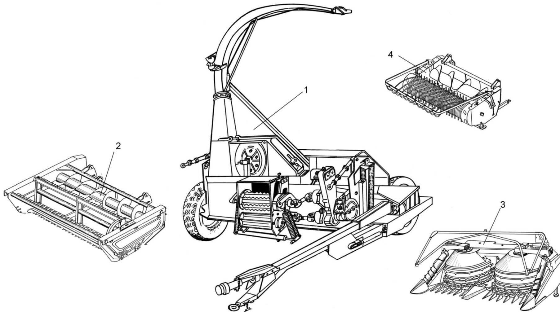
Рисунок 1 – Комбайн кормоуборочный прицепной КДП-3000 КПТ 0000000Б
