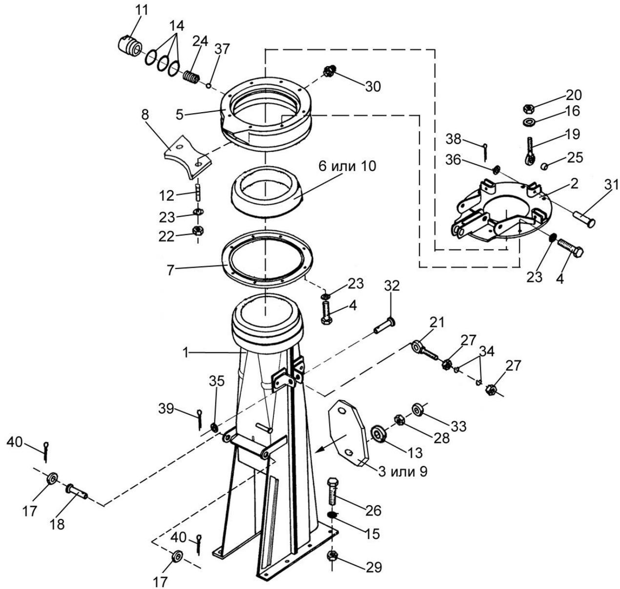
Рисунок 53 – Основание силоспровода КПТ 0103000Б
