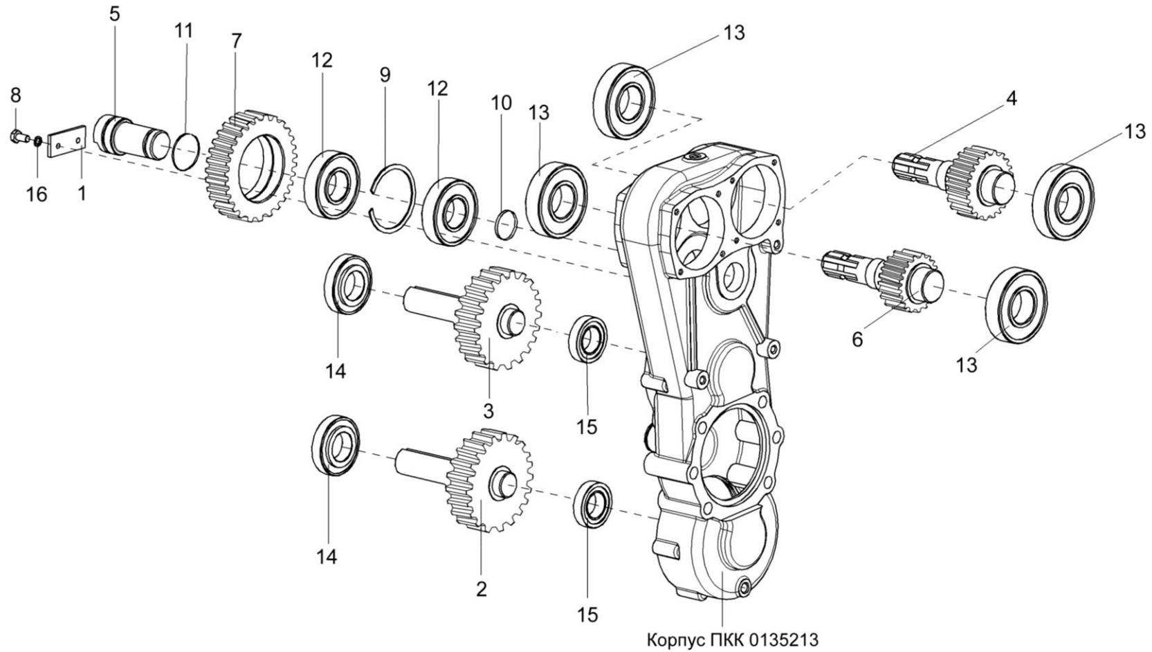
Рисунок 34 – Редуктор цилиндрический ПКК 0135170 (валы и шестерни)
