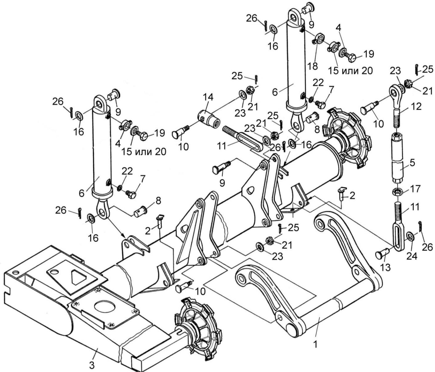
Рисунок 4 – Рама со ступицами, стяжки, торсион, гидроцилиндры
