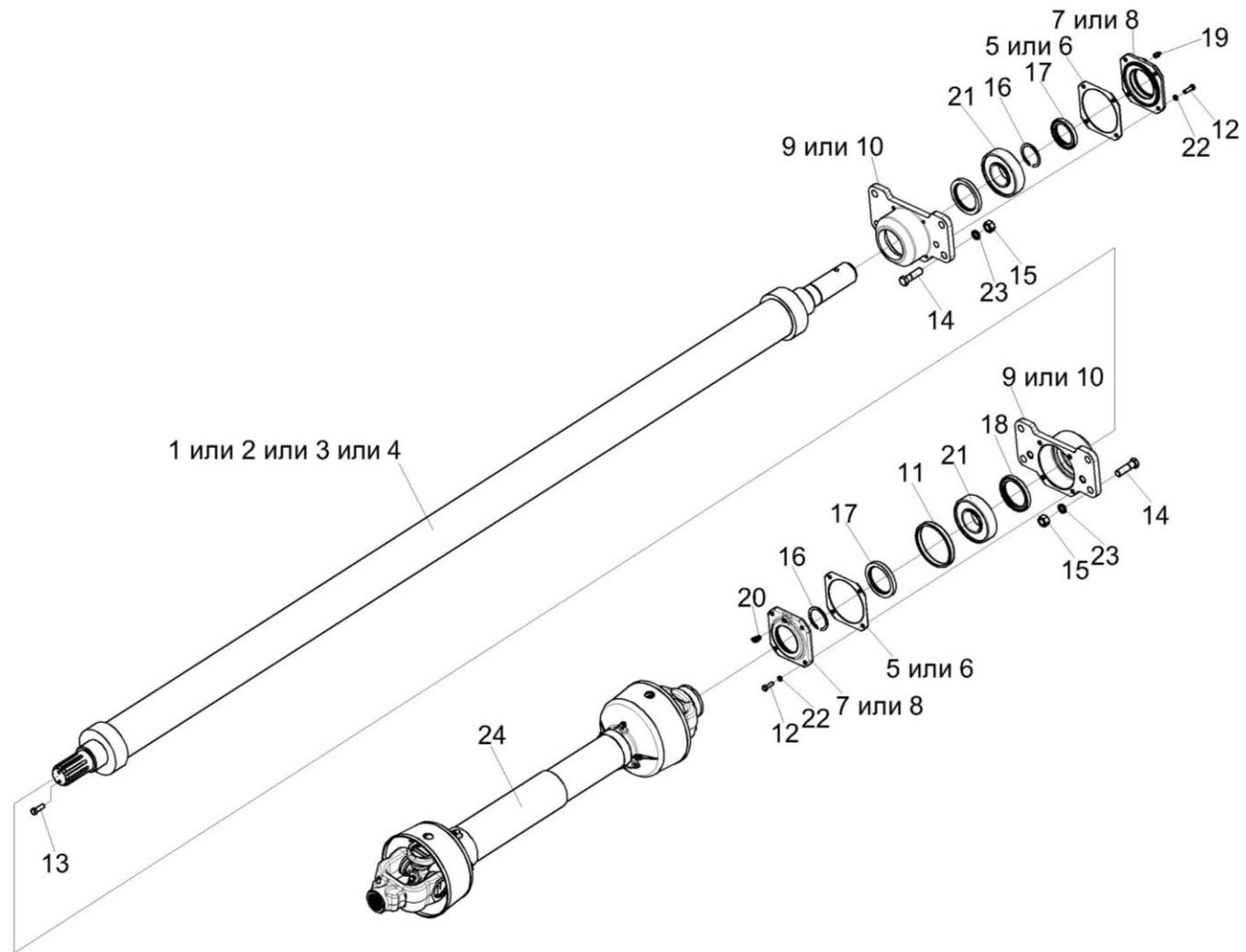
Рисунок 11 – Установка вала снцы (вариант со сцепным устройством)
