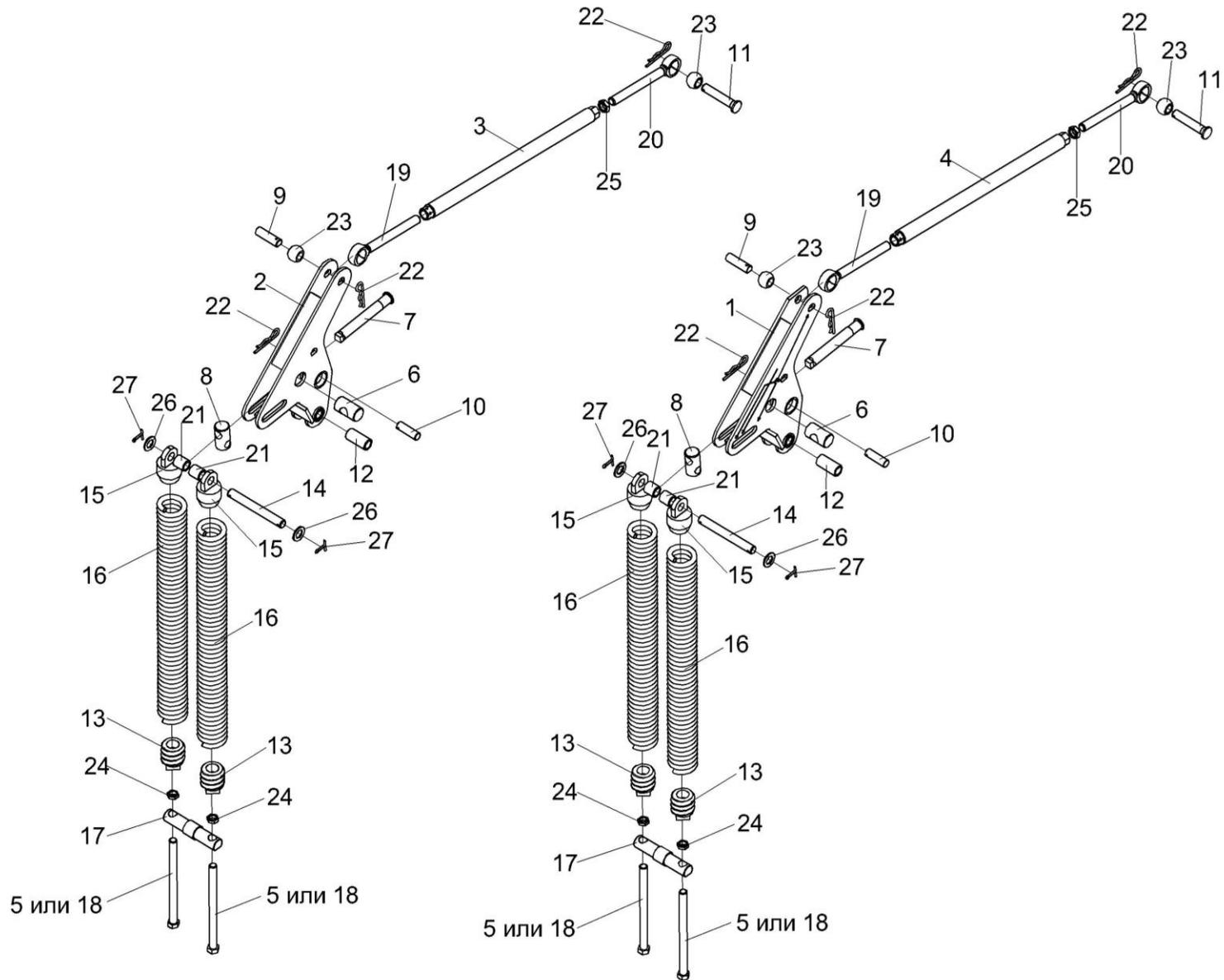
Рисунок 58 – Механизмы продольного копирования ПКК 0455000 и ПКК 0455000-01
