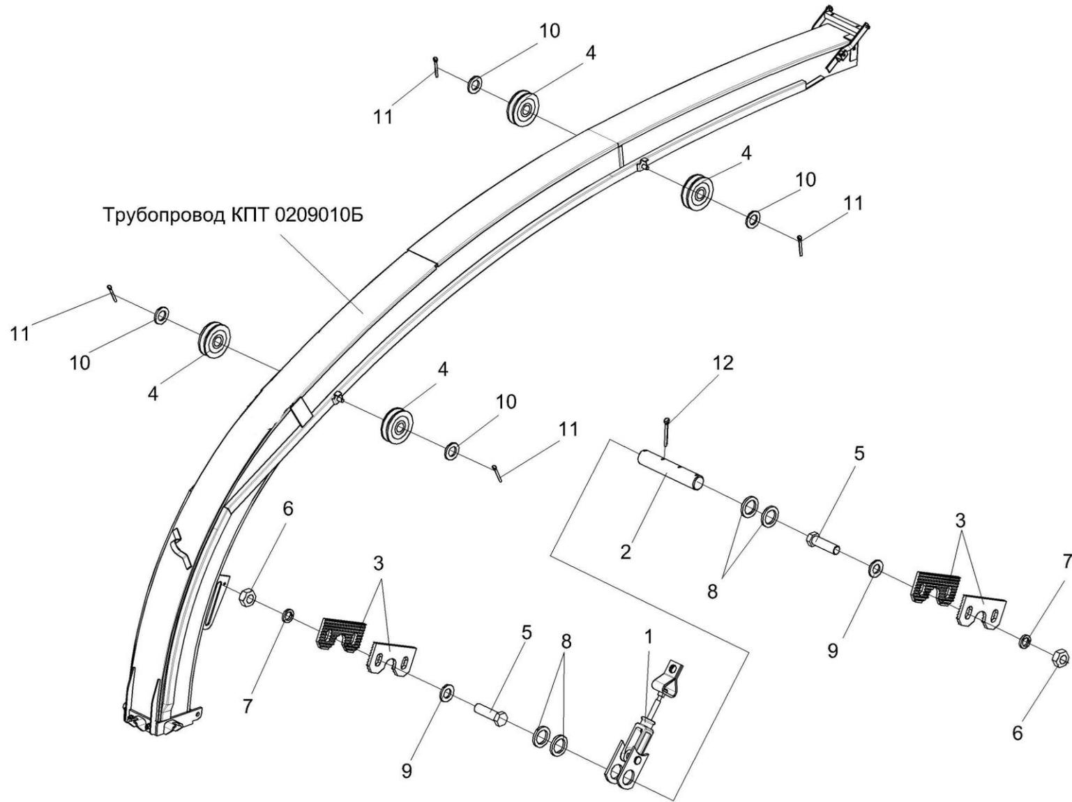
Рисунок 56 – Силовопровод КПТ 0209000А (установка устройства натяжного)
