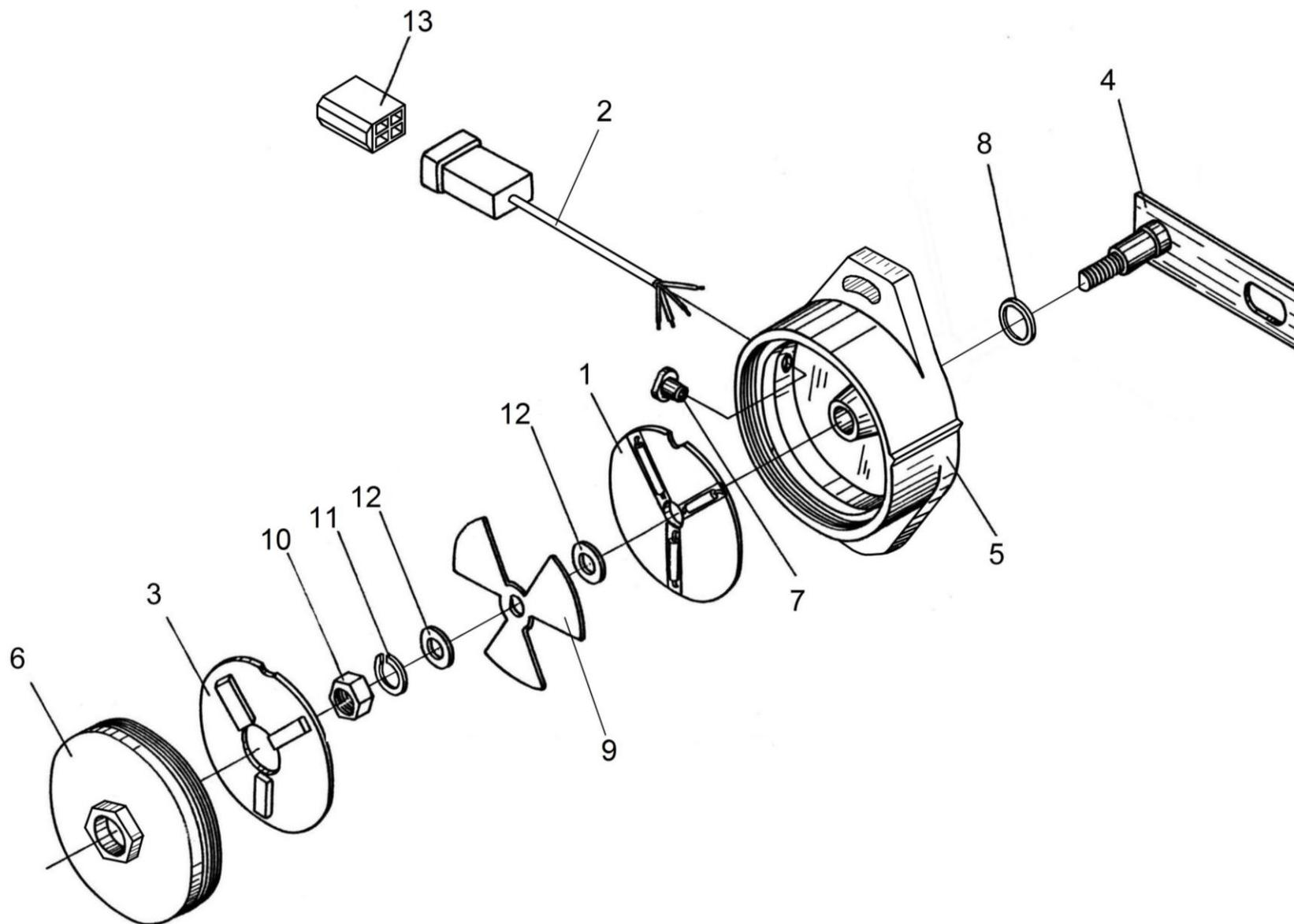
Рисунок 52 – Датчик положения ПКК 0152000В
