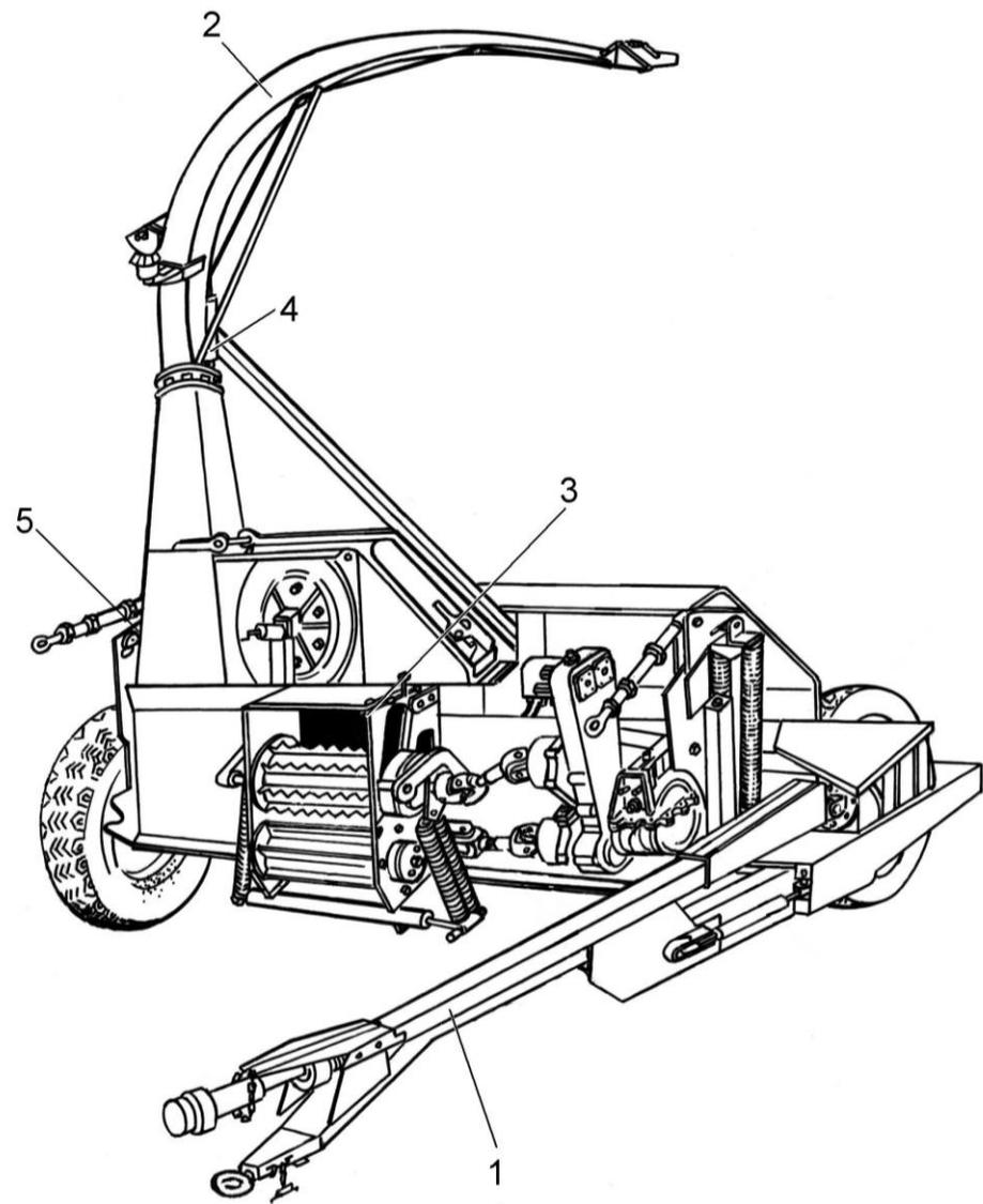
Рисунок 2 – Измельчитель прицепной КПТ 0000010Б
