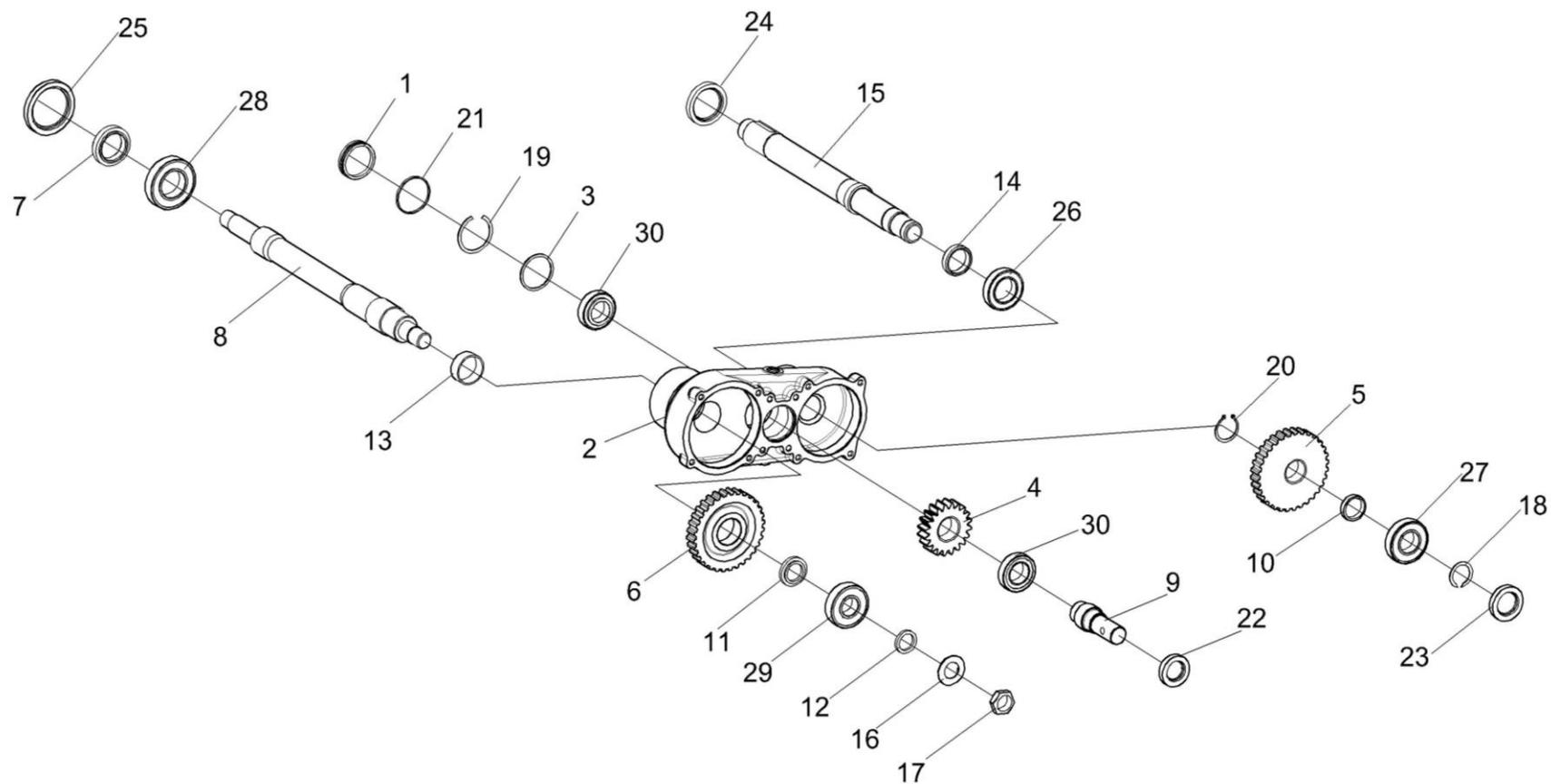
Рисунок 44 – Редуктор цилиндрический подпрессовывающих вальцев ПКК 0118000Б-01 (лист 2)
