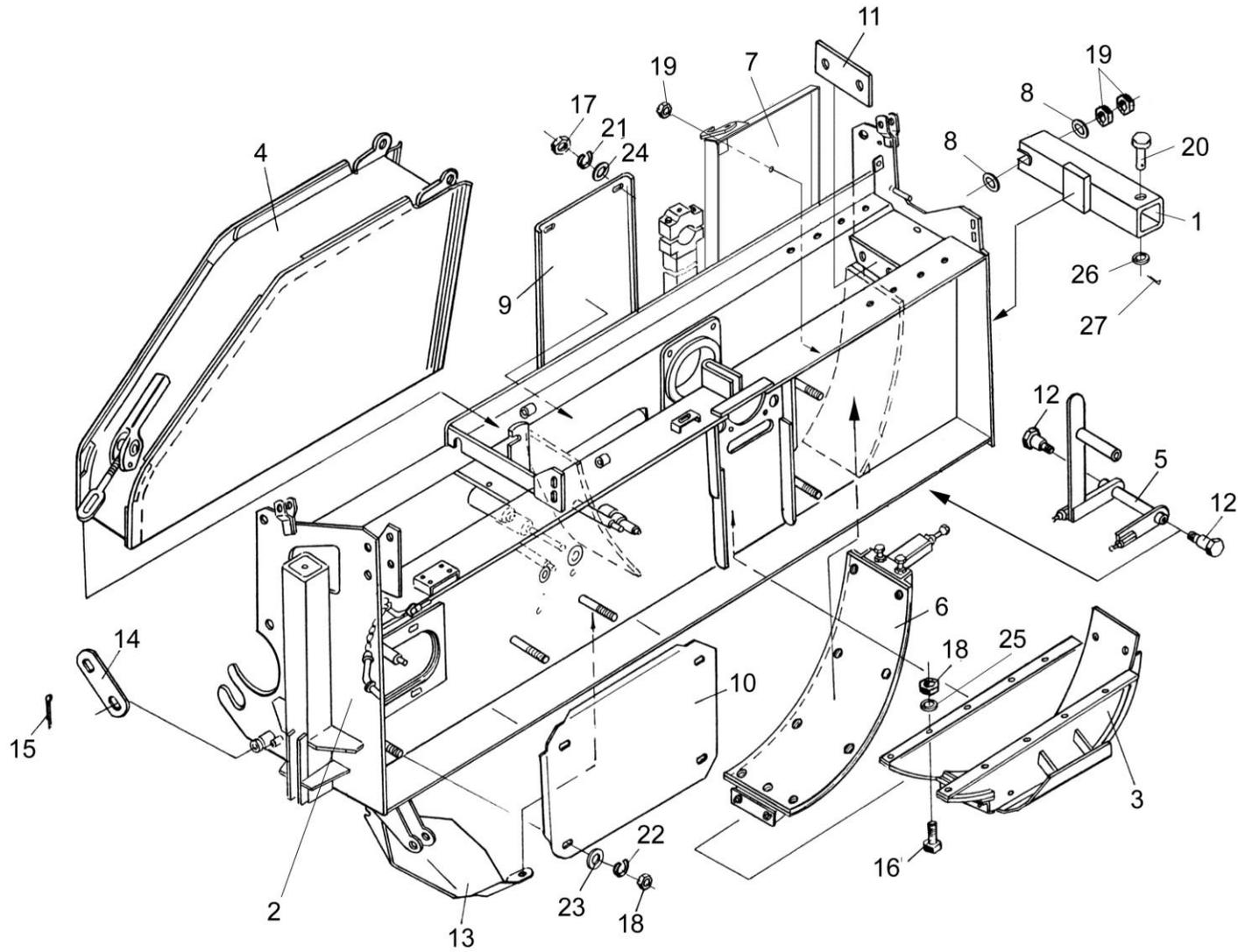
Рисунок 22 – Установка рамы измельчителя ПКК 0101000А-03
