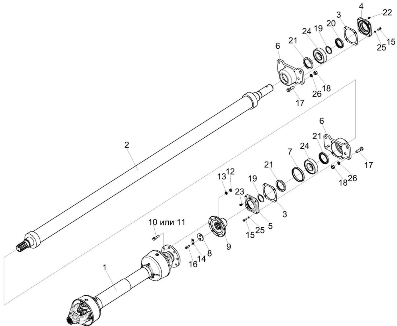
Рисунок 9 – Установка вала сницы
