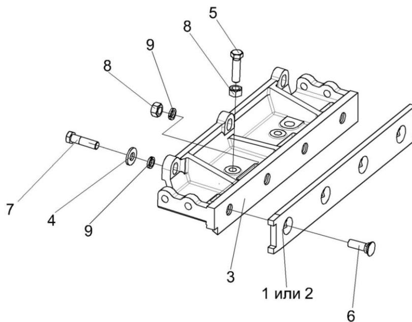
Рисунок 51 – Противорез ПКК 0100170
