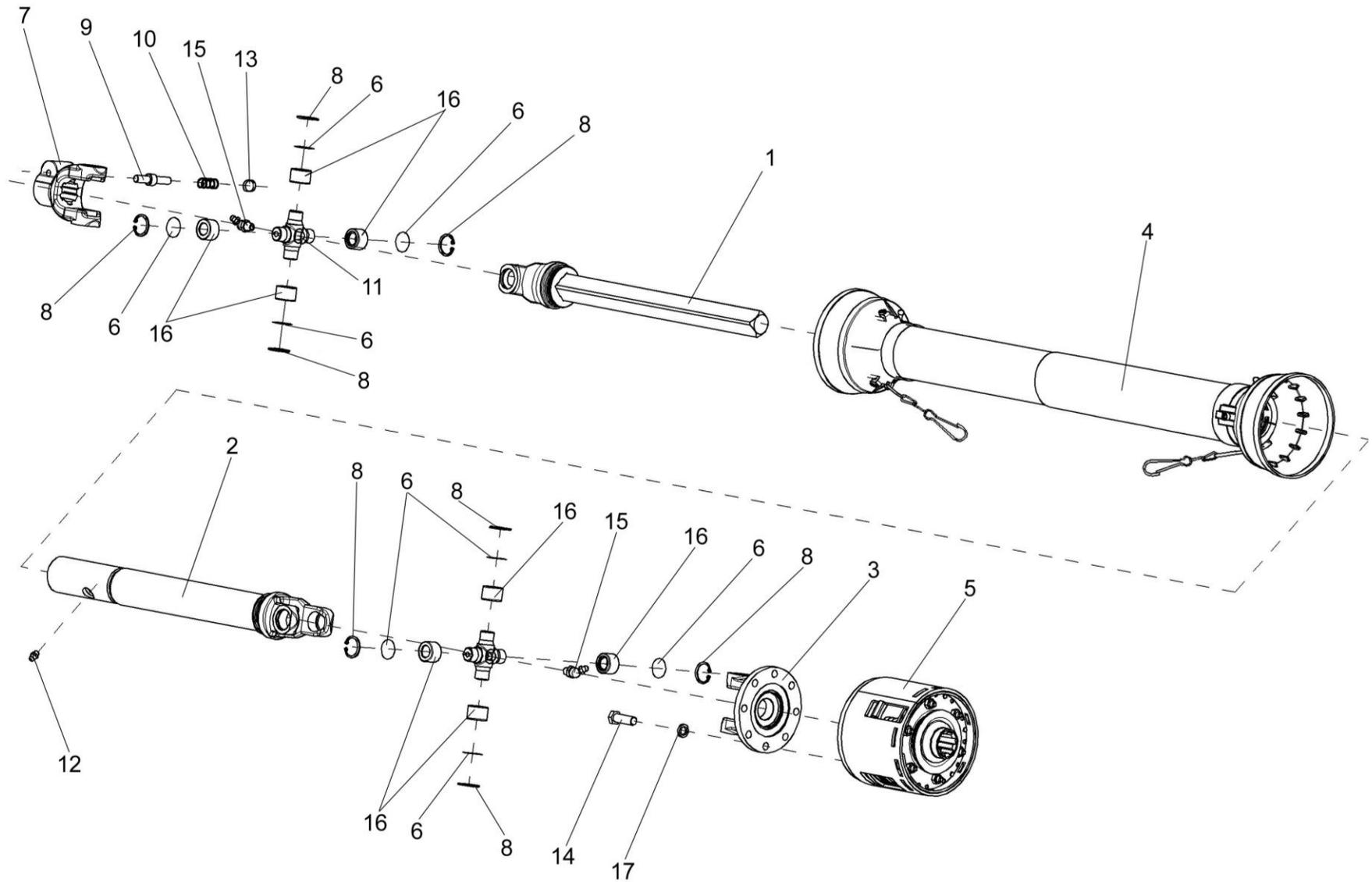
Рисунок 36 – Вал карданный телескопический с защитным кожухом ПКК 0140000
