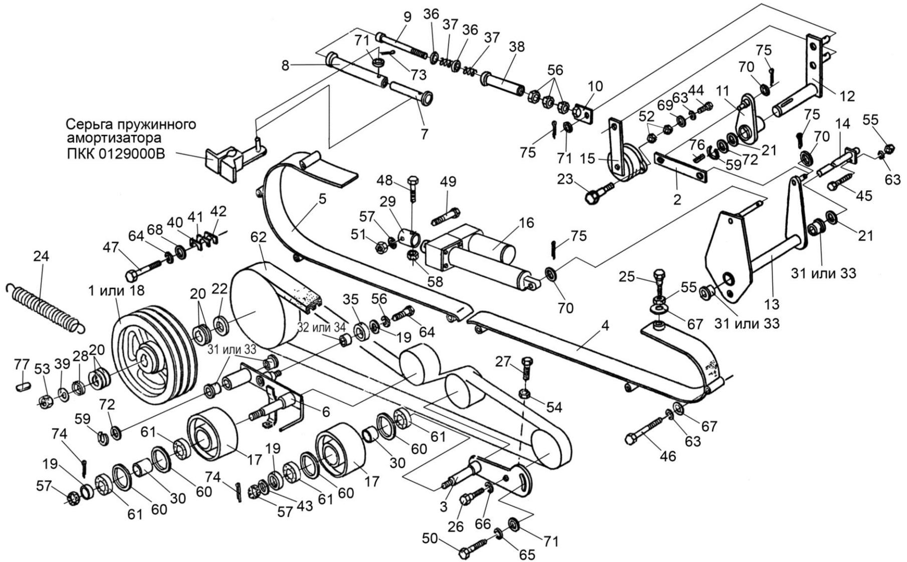
Рисунок 46 – Шкивы, ограждения привода ротора измельчителя
