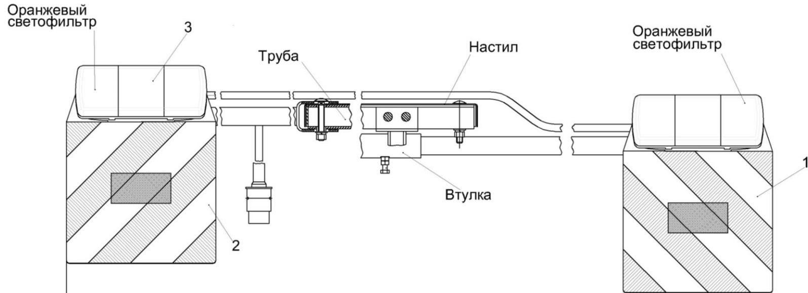
Рисунок 19 – Установка оборудования светосигнального КПТ 0700100
