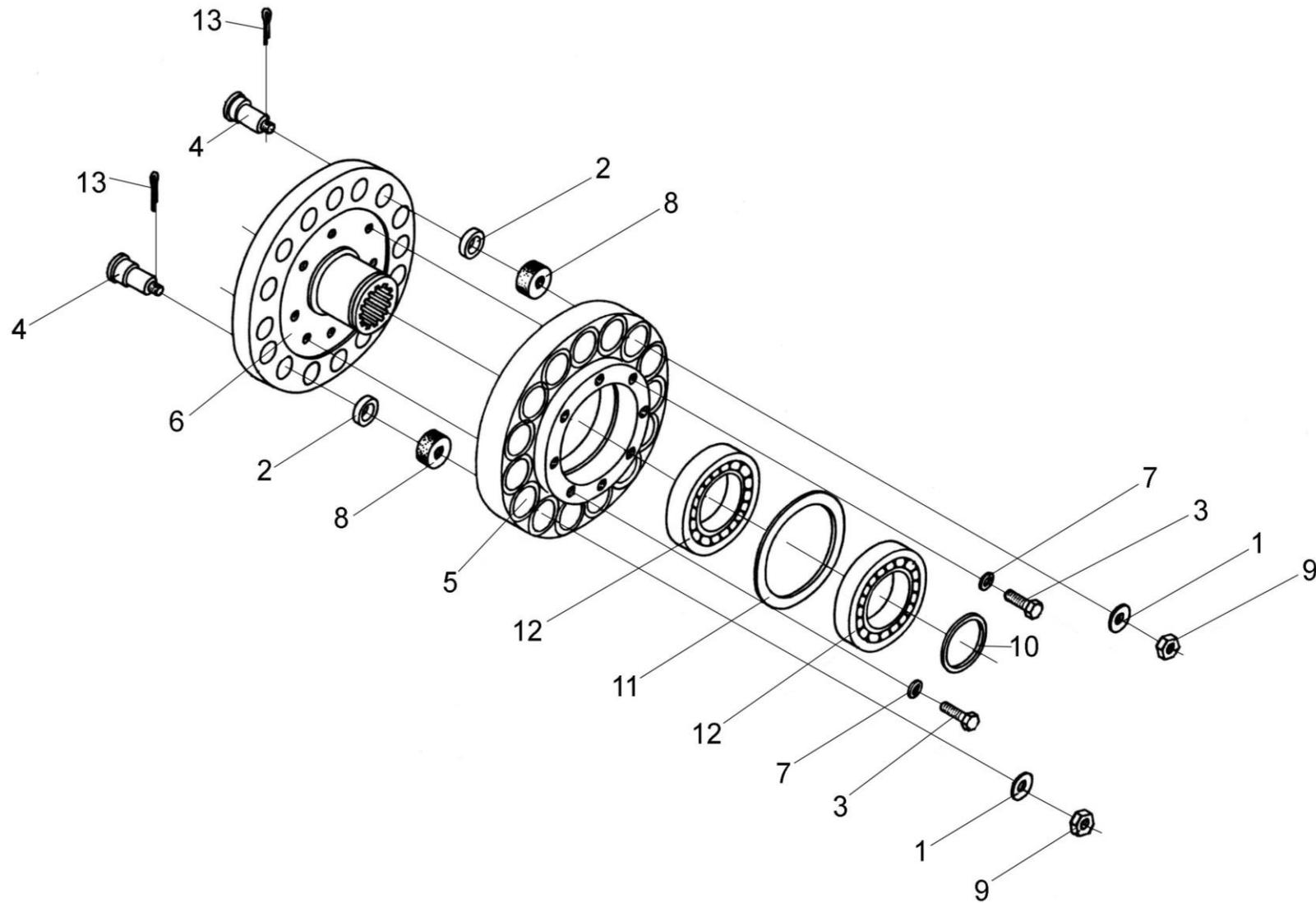
Рисунок 14 – Муфта упругая втулочно-пальцевая КПТ 0100500
