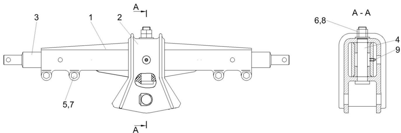
Рисунок 12 – Устройство сцепное КПТ 0303210
