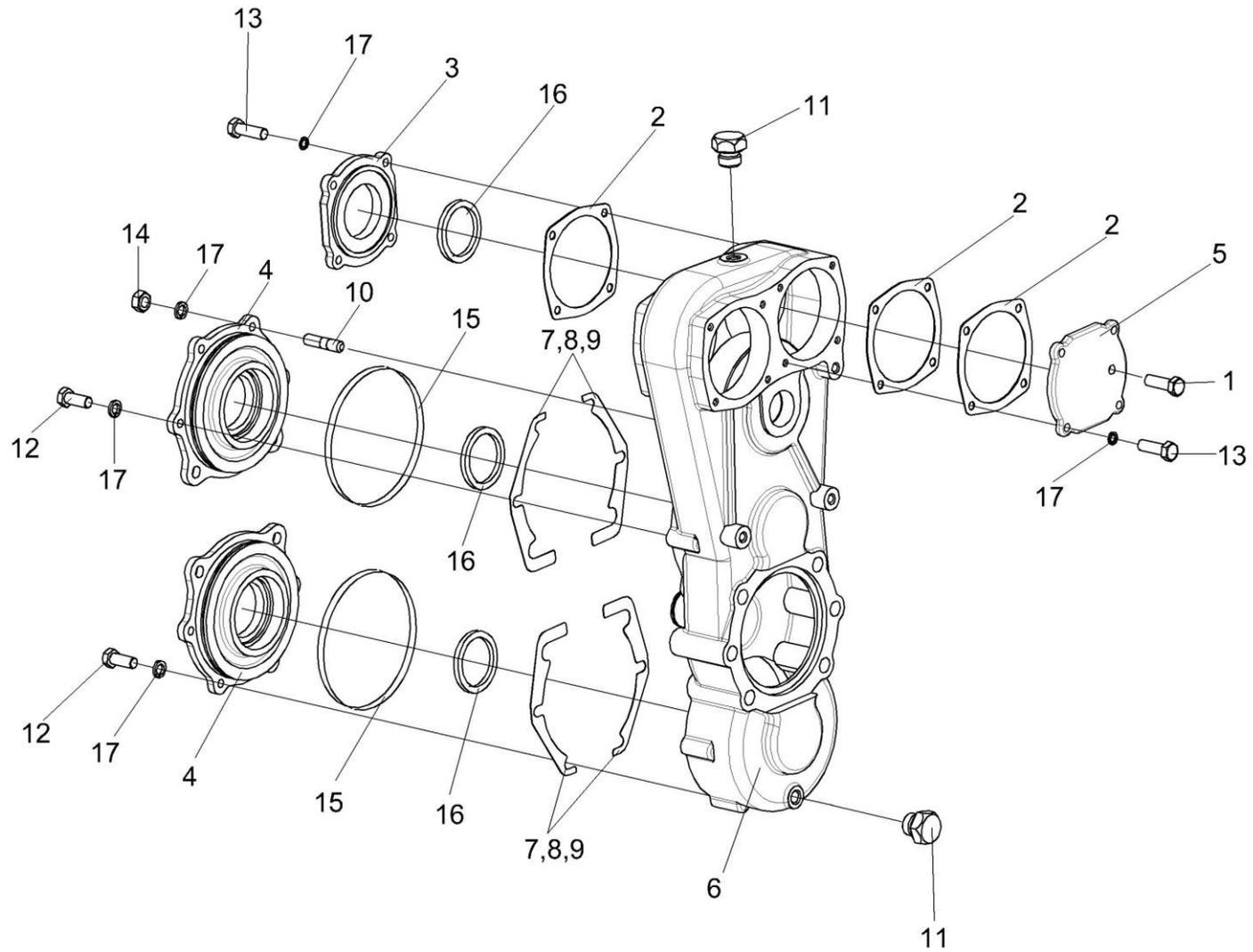
Рисунок 33 – Редуктор цилиндрический ПКК 0135170 (корпус и крышки)
