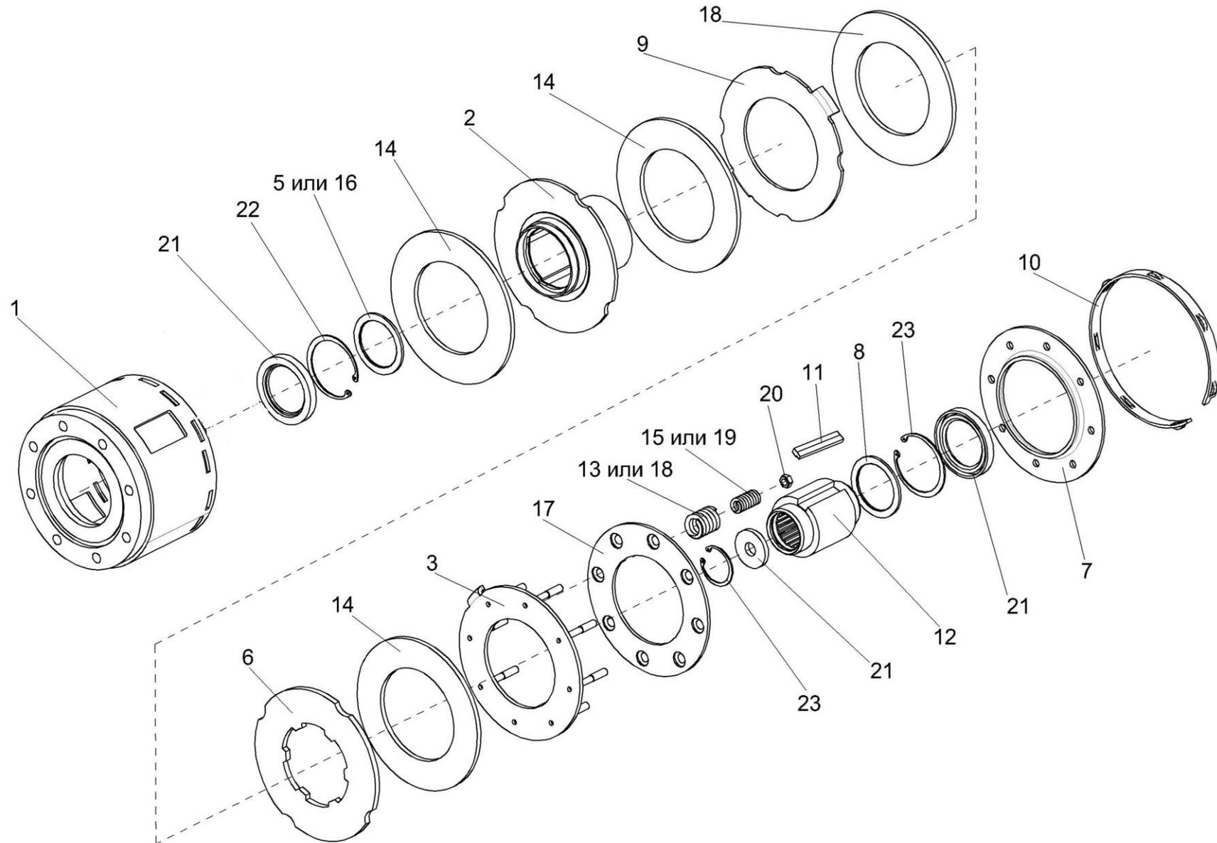
Рисунок 49 – Муфта предохранительная обгонная 04.142.000
