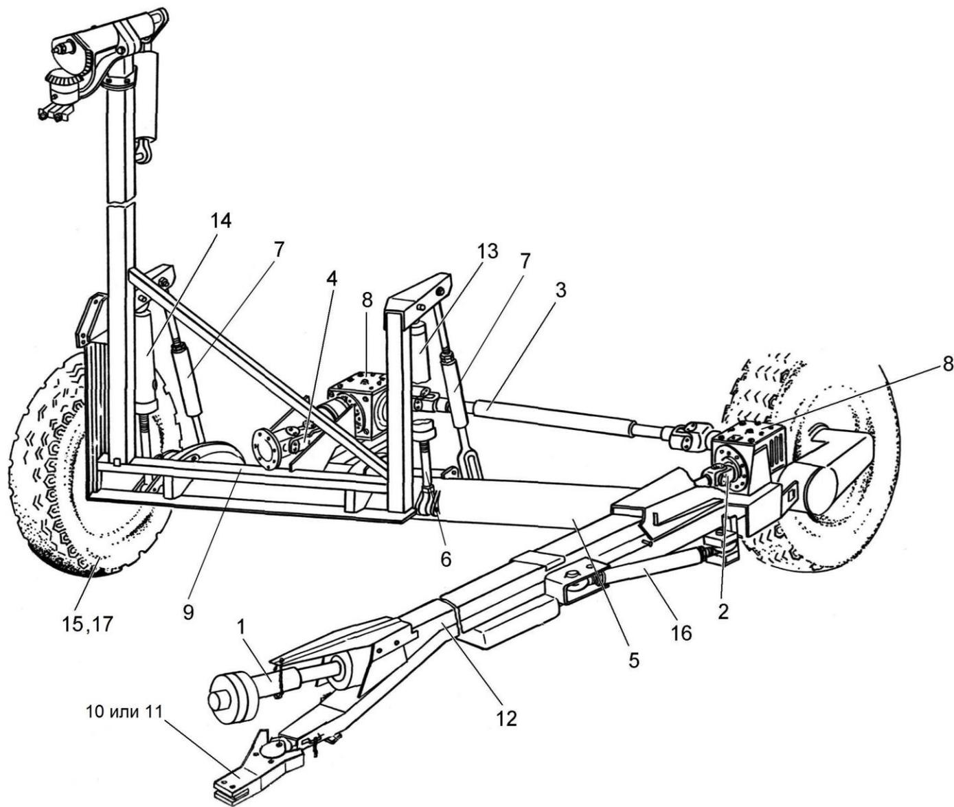
Рисунок 3 – Шасси прицепное КПТ 010000Б
