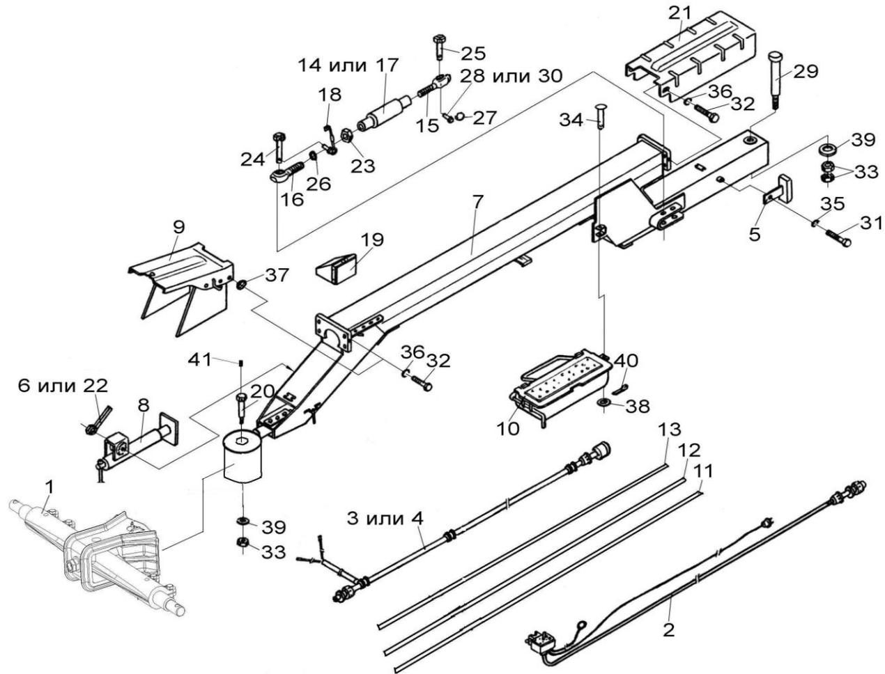
Рисунок 10 – Установка сницы КПТ 0300000В-02 и КПТ 0300000В-03
