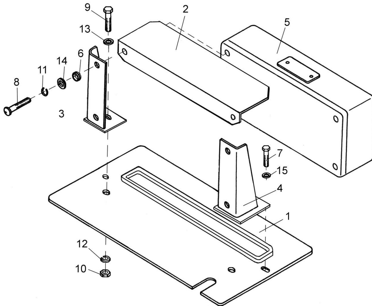
Рисунок 26 – Панель ПКК 0100030Б
