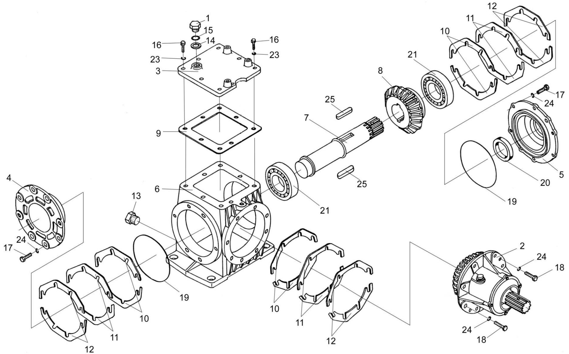
Рисунок 15 – Редуктор конический КПТ 0104000Б
