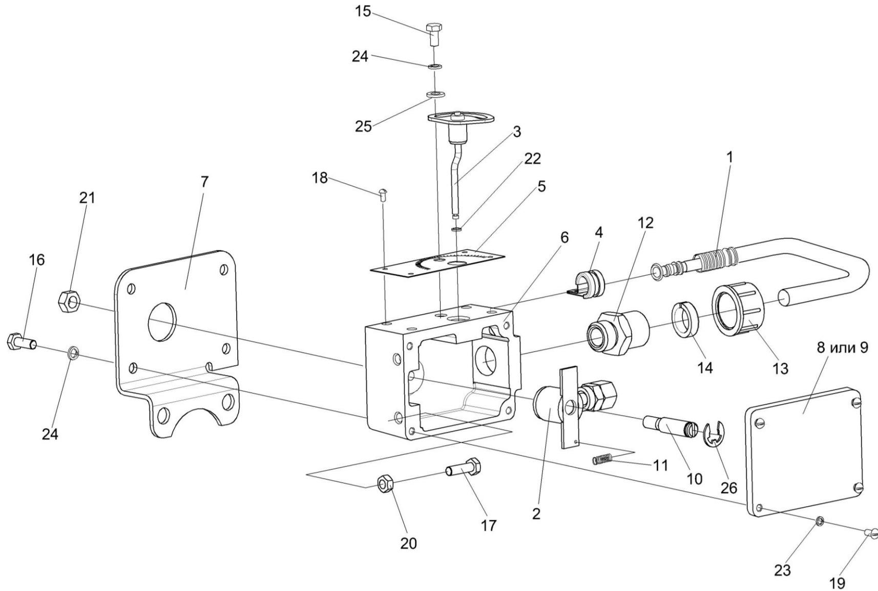
Рисунок 45 – Датчик камнедетектора ПКК 0108320Б
