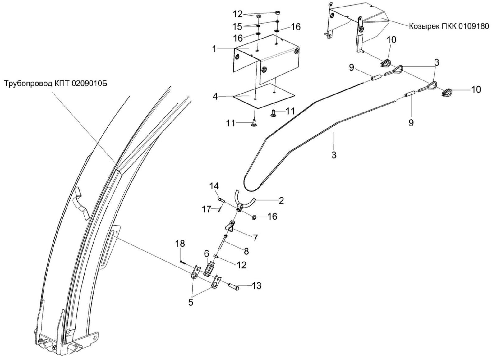
Рисунок 57 – Устройство натяжное, канат, козырьки силосопровода
