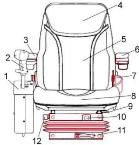
1 – блок управление; 2 – рукоятка управления скоростью движения; 3, 6 – подлокотники; 4 – подголовник; 5 – спинка; 7 - ремень безопасности; 8 – подушка сиденья; 9 – рычаг фиксации наклона спинки; 10 – кнопка регулировки системы поддрессоривания сиденья по массе оператора; 11 – маховик регулировки сиденья по высоте; 12 - рычаг фиксации продольного перемещения сиденья;
