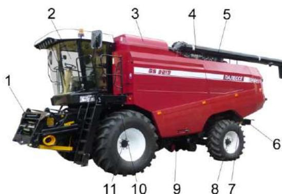
1 – наклонная камера; 2 - кабина; 3 – бункер зерновой; 4 - установка двигателя; 5 – шнек выгрузной; 6 – соломоизмельчитель с дефлектором; 7 - половоразбрасыватель; 8 – мост управляемых колес; 9 - очистка; 10 – молотильный аппарат; 11 – мост ведущих колес
