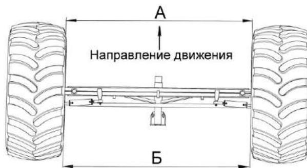
Рисунок 2.27 - Регулировка сходимости колес
