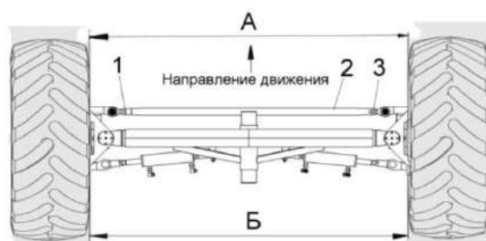
Рисунок 2.32 – Регулировка сходимости управляемых колес
