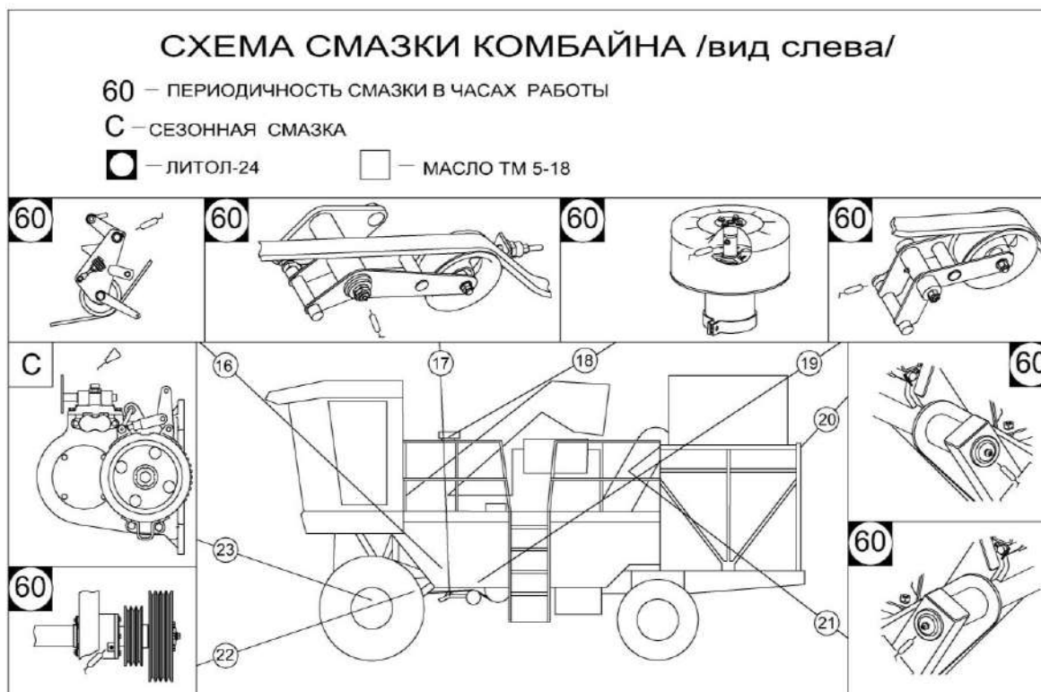
Рисунок 3.2 – Схема смазки комбайна (вид слева)
