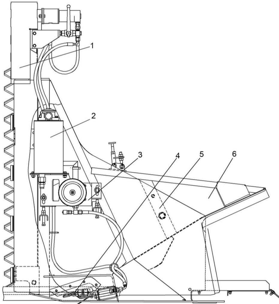
1 – активный делитель; 2 – гидросистема; 3 – установка гидронасоса; 4 – режущий аппарат; 5 – ограждение; 6 – рама
