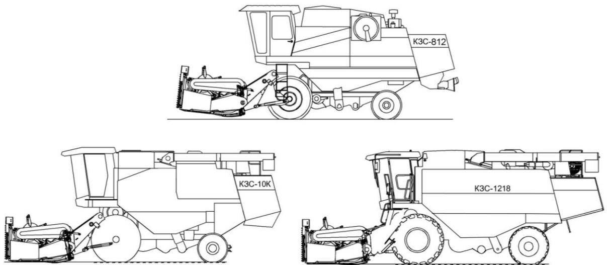
Рисунок 1.1 – Общие виды комбайнов КЗС-812, КЗС-1218, КЗС-10К с жатками для зерновых культур и приспособлениями для уборки рапса
