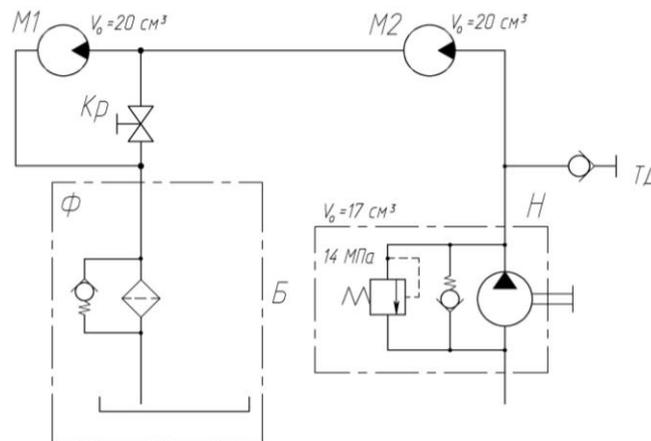
Б – бак масляный; М1, М2 – гидромоторы привода рапсовых делителей; Н – насос; Ф – фильтр; Кр – кран; ТД – точка диагностическая
