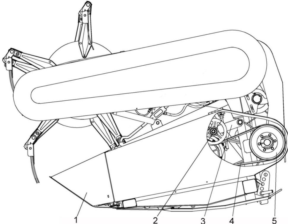
1 – ограждение; 2 – стяжка; 3 – устройство натяжное; 4 – ремень привода режущего аппарата; 5 – шкив
