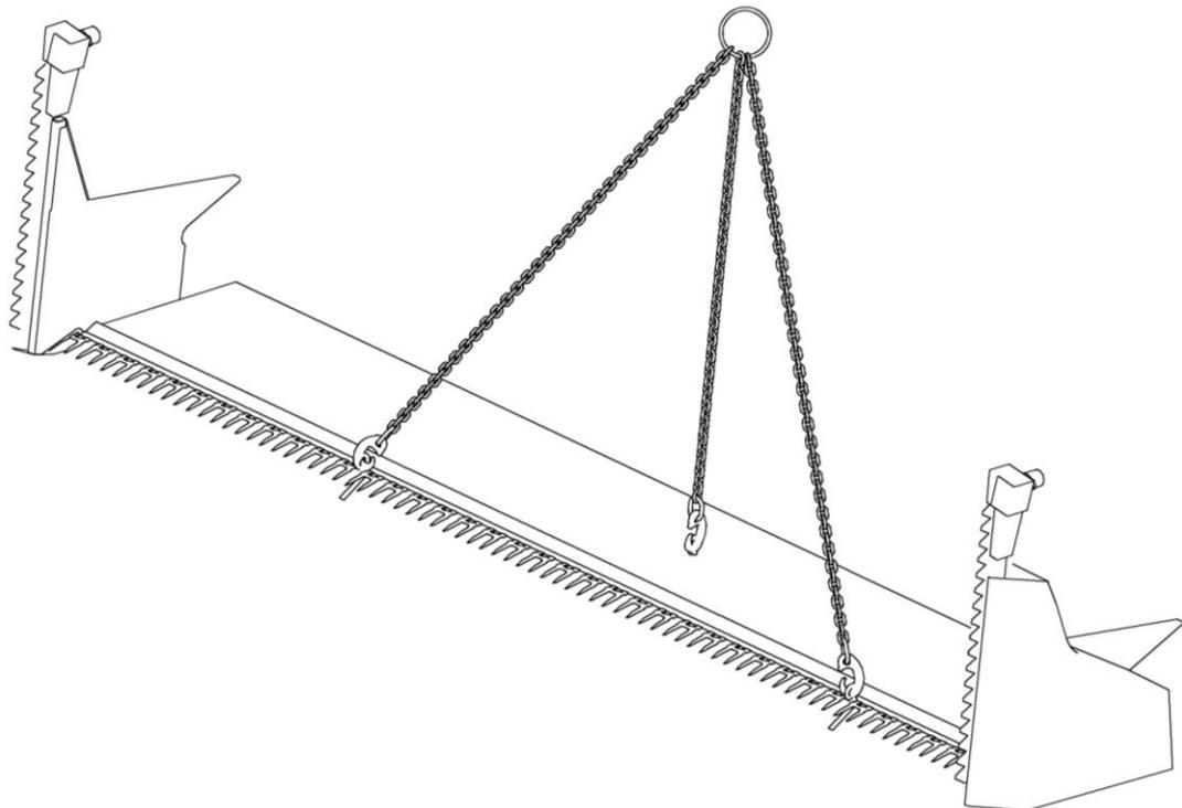
Рисунок 6.1 – Схема строповки
