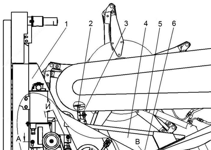
1 – ограждение; 2 – винт; 3 – кронштейн; 4 – приспособление для уборки рапса; 5 – гайки; 6 – щитки
