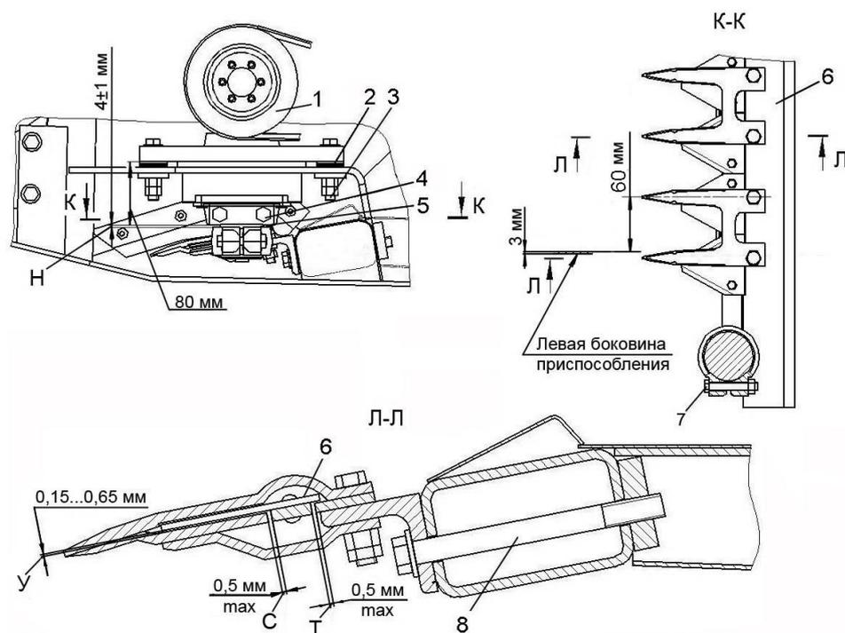
1 – угловая передача; 2 – регулировочные прокладки; 3, 7, 8 – болты; 4 – винт; 5 – водило; 6 – режущий аппарат
