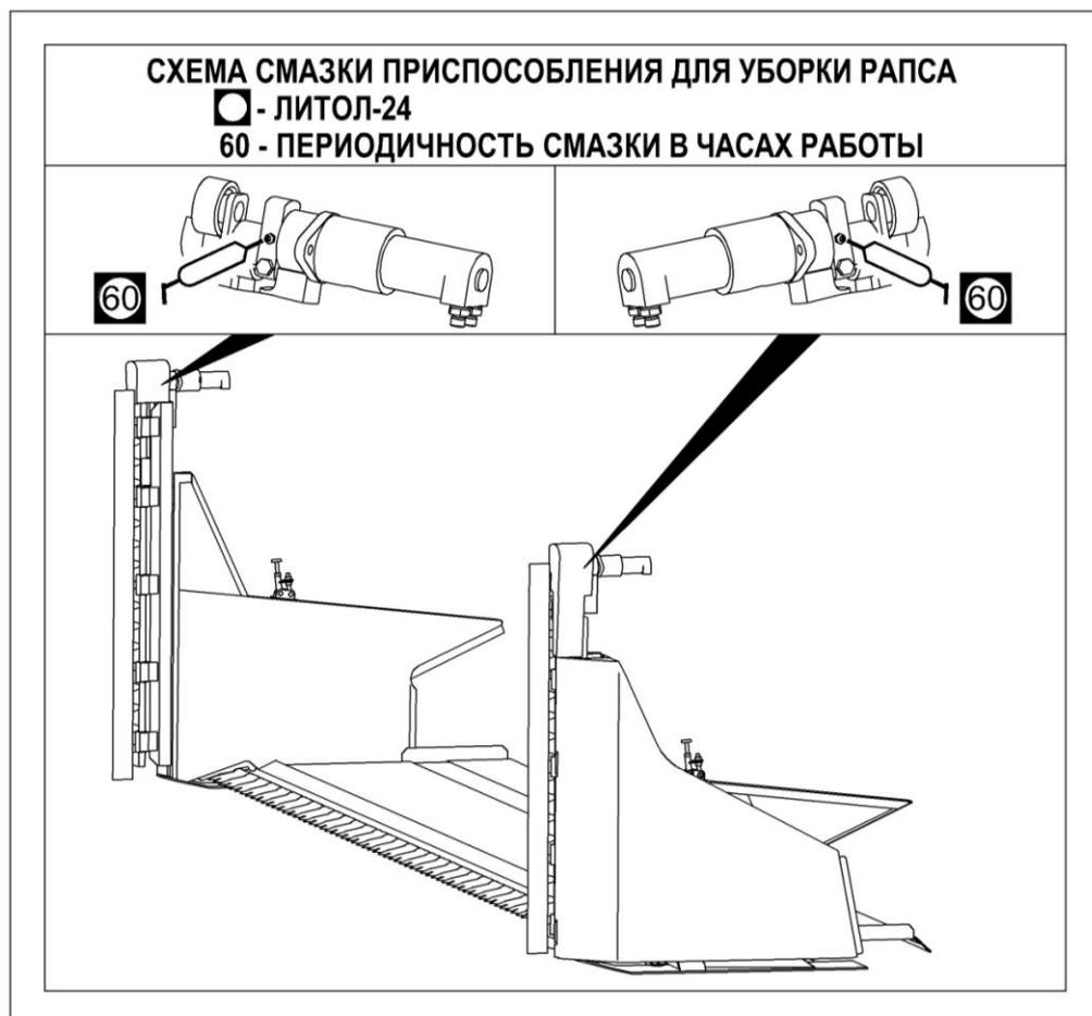
Рисунок 3.1 – Схема смазки жатки
