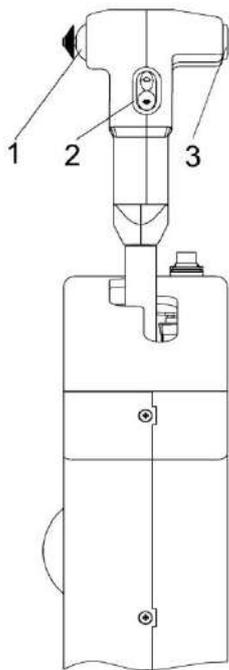
1 – переключатель управления силосопроводом; 2 – переключатель подъема/опускания адаптера; 3 – выключатель аварийного останова приводов питающего аппарата и адаптера
