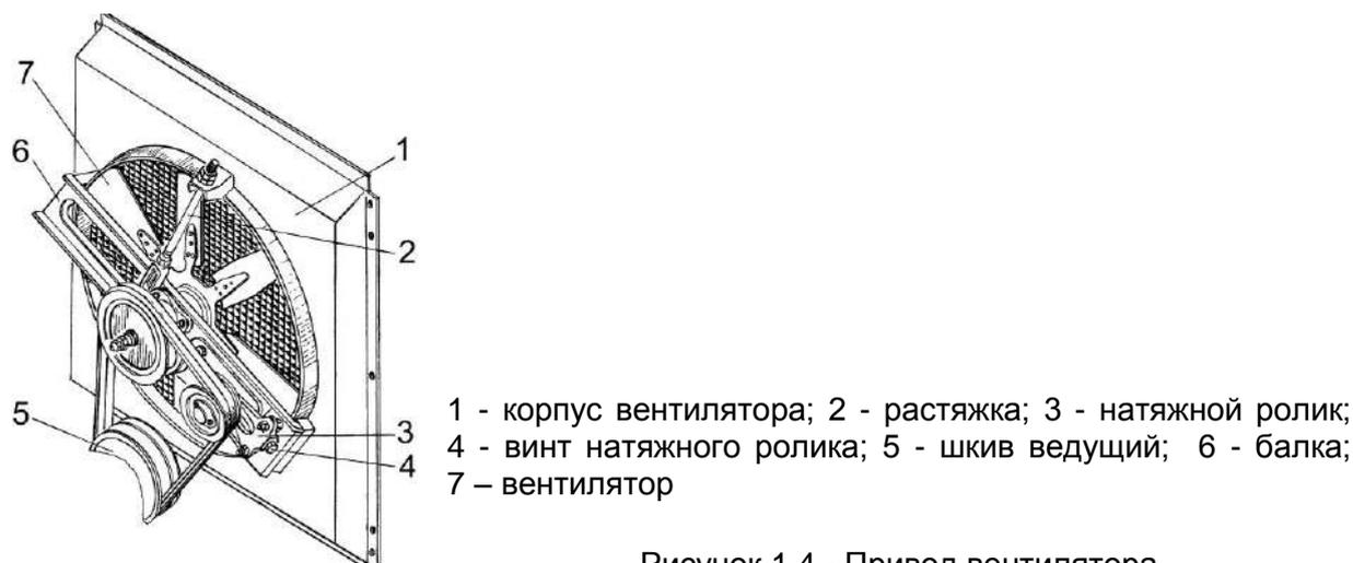
Рисунок 1.4 - Привод вентилятора
