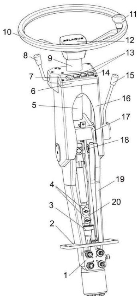
1 - насос дозатор; 2, 17 – кронштейны; 3 – опора; 4, 18 – оси; 5 – рулевой вал; 6 – крышка; 7 – выключение аварийной сигнализации; 8 – подрулевой переключатель; 9 – колпак; 10 – колесо рулевое; 11 – ручка; 12 – крышка; 13 - контрольные лампы указателей поворотов; 14 - контрольная лампа дальнего света; 15 - рукоятка фиксации угла наклона колонки; 16 - кожух; 19 – стойка; 20 – втулка
