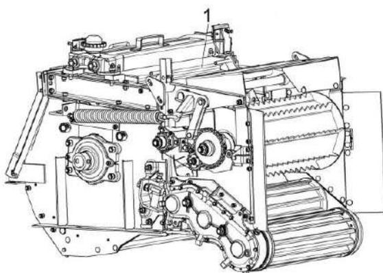
1 – крышка измельчающего барабана
