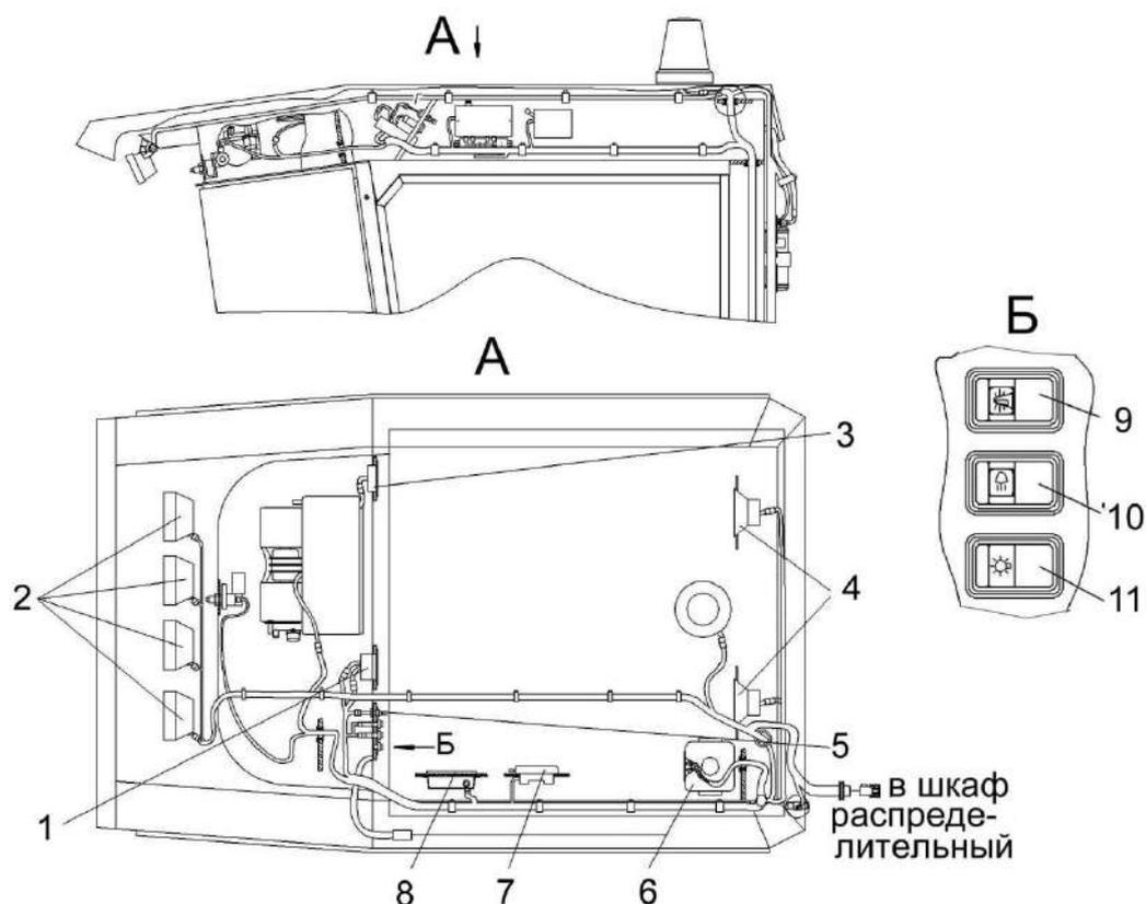
1 – блок индикации частоты (БИЧ); 2 – рабочие фары; 3 – пульт управления климатической установкой; 4 – акустическая система; 5 – выключатель стеклоочистителя и стеклоомывателя; 6 – бачок стеклоомывателя; 7 – плафон освещения салона; 8 – преобразователь напряжения; 9 – выключатель маяка сигнального; 10 – выключатель включения/выключения рабочих фар и фары силосопровода; 11 – выключатель включения/выключения габаритов, подсветки приборов, транспортных фар
