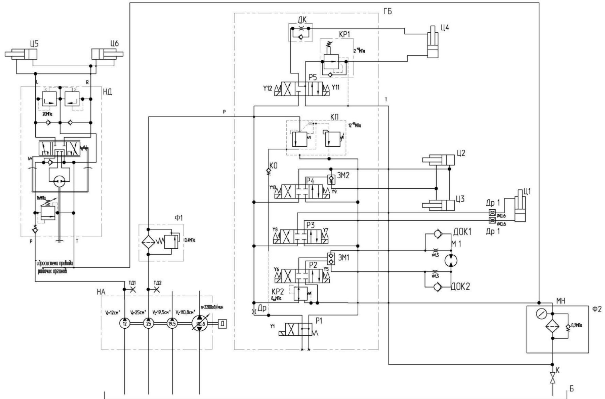
Б – масляный бак; ГБ – гидроблок; P1 - P5 – гидрораспределители; ЗМ1, ЗМ2 – гидрозамки; Др – демпфер; ДК – гидродроссель с обратным клапаном; КП – предохранительный клапан; КР1, КР2 – редукционные клапана; КО – обратный клапан; К – кран; Др1, Др2 – гидродроссели; М1 – гидромотор поворота силосопровода; НА – тандем насосов; НД – насос-дозатор; ТД1, ТД2 – резьбовые соединения с колпачком; Ф1, Ф2 - фильтры
