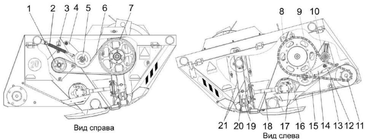
1 – шкив; 2 – пружина; 3 – болт; 4, 14 – натяжные устройства; 5 – шкив натяжения привода мотовила; 6 – ременная передача привода мотовила; 7 – шкив привода мотовила; 8 – звездочка с предохранительной муфтой; 9 – шкив натяжения привода режущего аппарата; 10 – натяжная звездочка; 11 – контрпривод; 12 – стяжка; 13 – цепная передача; 15 – ременная передача привода режущего аппарата; 16 – шкив вала привода режущего аппарата; 17 – качающаяся шайба; 18 – колебатель; 19 – шатун; 20 – вилка; 21 – тяга
