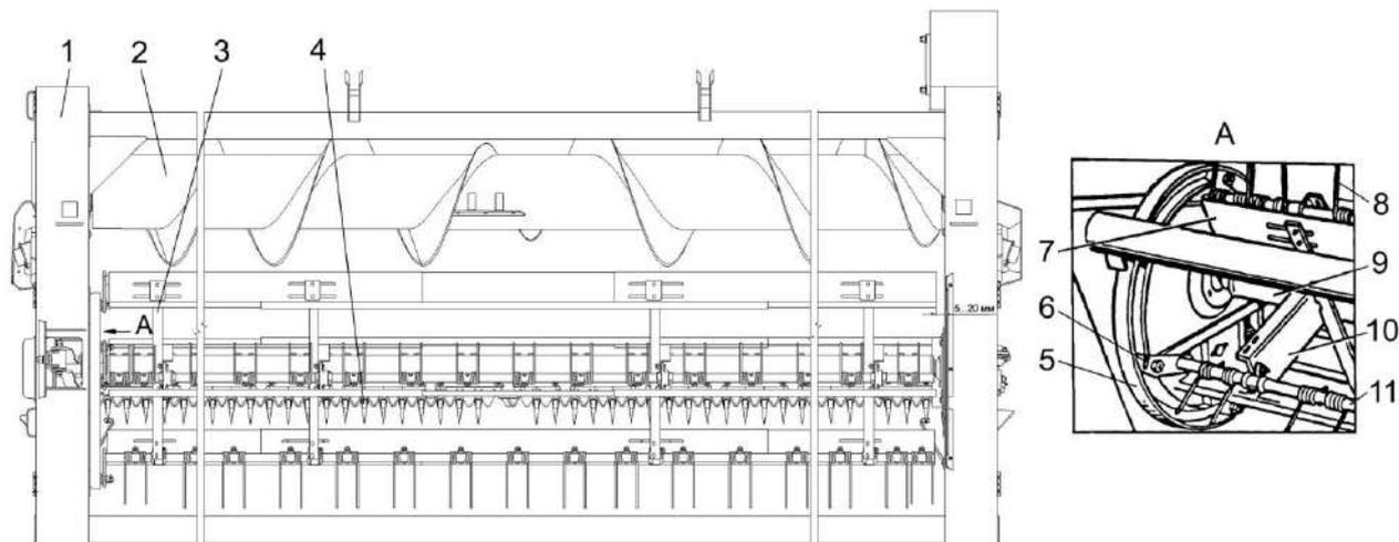
1 – рама; 2 – шнек; 3 – мотовило; 4 – режущий аппарат; 5 – направляющая дорожка; 6 – ролик; 7 – планка мотовила; 8 – пружинный зуб; 9 – вал мотовила; 10 – держатель; 11 - граблина
