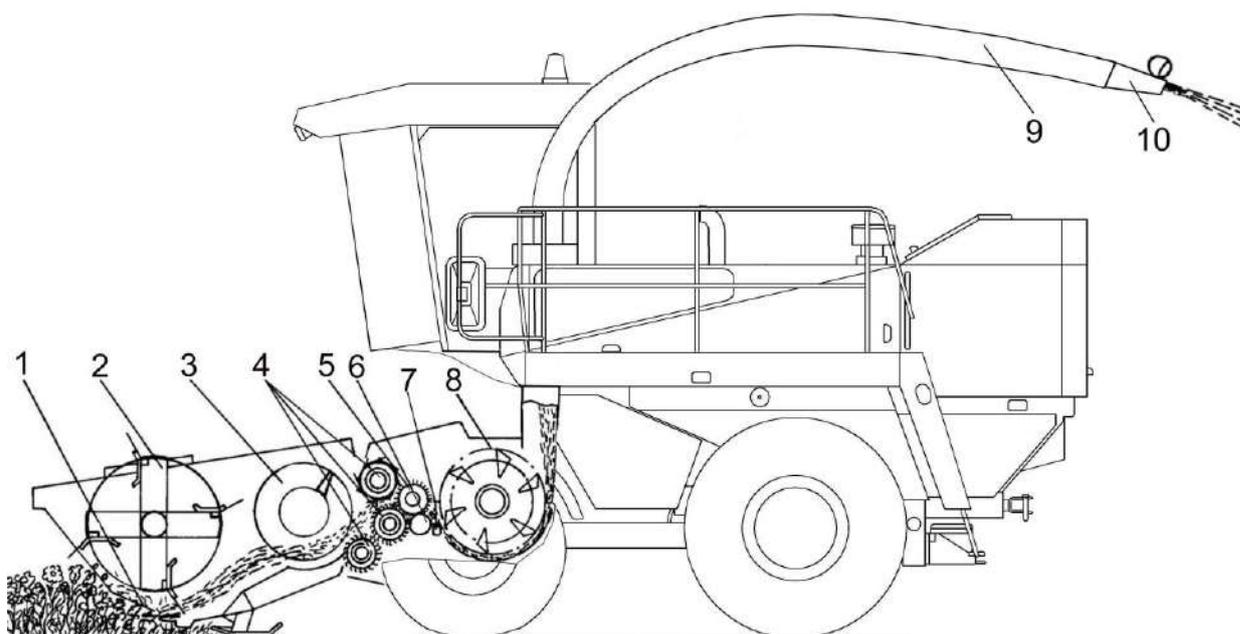
1 – режущий аппарат; 2 – мотовило; 3 – шнек; 4 – вальцы передние; 5 – подпрессовывающий валец; 6 – валец гладкий; 7 – противорежущий брус; 8 – измельчающий барабан; 9 – силосопровод; 10 – козырек
