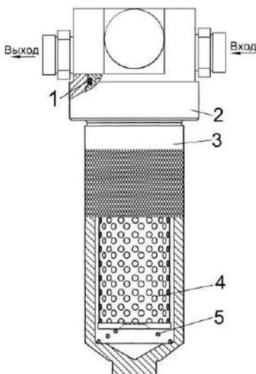
1 – уплотнительное кольцо; 2 – головка фильтра; 3 – стакан; 4 – фильтроэлемент; 5 – пружина
