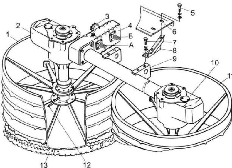
1, 11 – барабаны; 2, 10 – конические редуктора; 3 – звездочка выходного вала; 4 – цилиндрический редуктор; 5, 7 – болты; 6 – крышка; 8, 9 – кронштейны; 12 – масленки; 13 – режущий ротор
