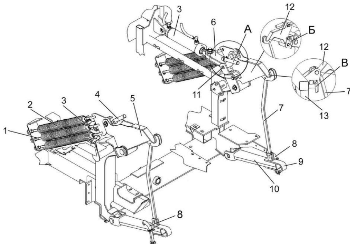
1 - стяжка; 2 – пружина; 3 - гидроцилиндр; 4 - верхний фиксатор; 5 - правый крюк; 6, 9 - скобы; 7 - тяга; 8 - нижний фиксатор; 10 - балка; 11 – палец; 12 - левый крюк; 13 – переходная рамка навешиваемой жатки для грубостебельных культур
