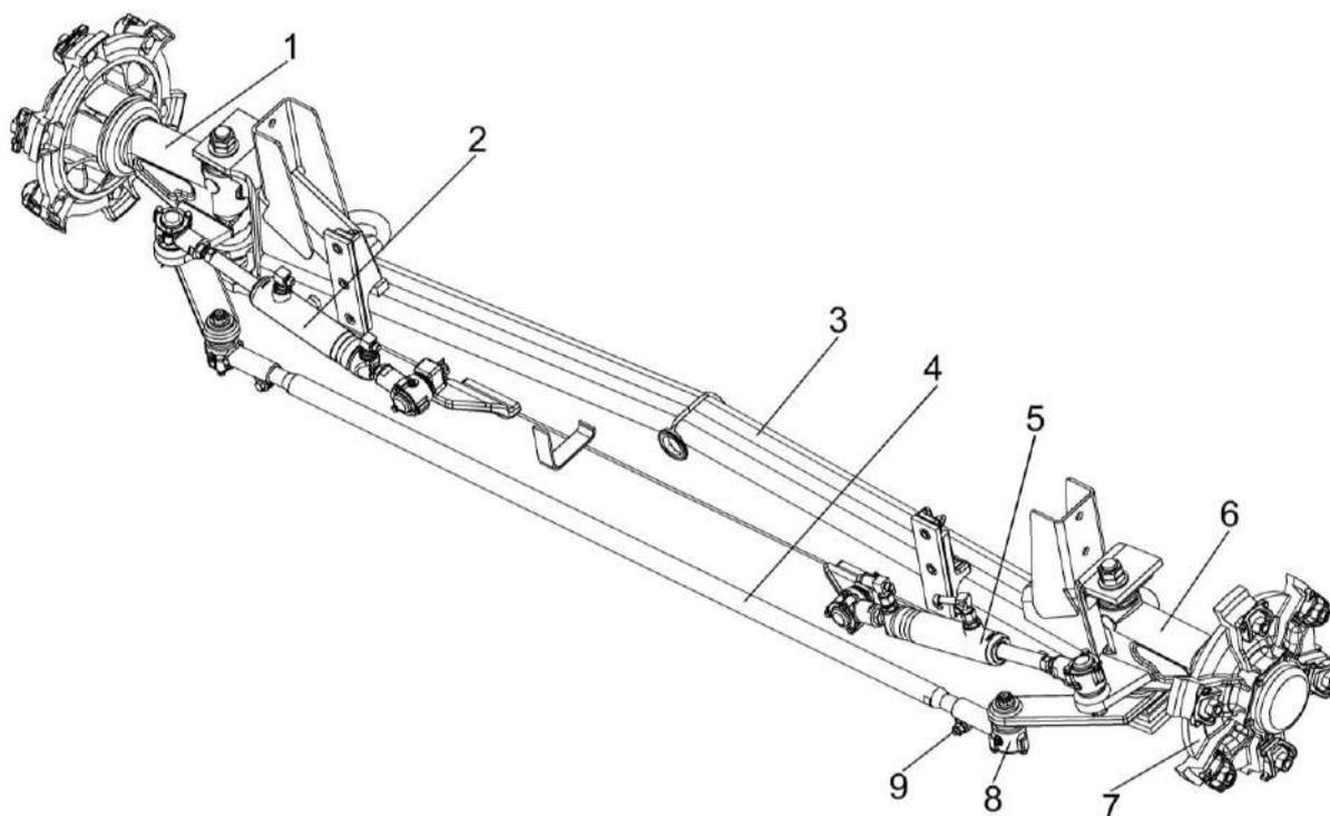
1, 6 – поворотные кулаки; 2, 5 – гидроцилиндры; 3 – балка; 4 – поперечная тяга; 7 - ступица; 8 – наконечник; 9 – стяжной болт
