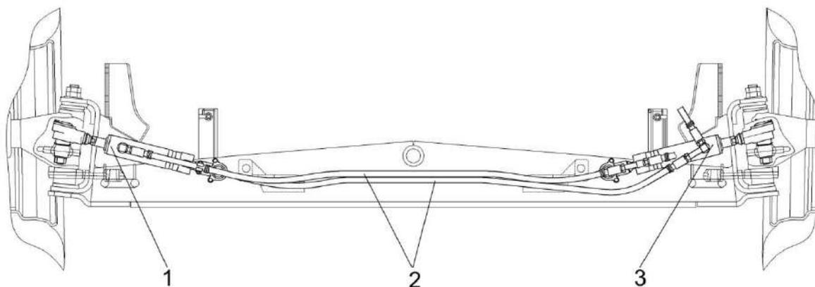
1, 3 – гидроцилиндры поворота управляемых колес; 2 – рукава высокого давления
