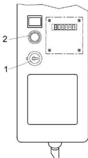
1 – замок зажигания; 2 – кнопка дистанционного управления выключателем МАССЫ
