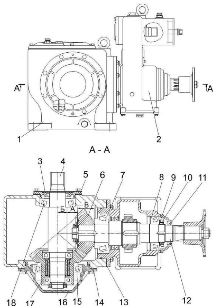
1 – корпус; 2 – мультипликатор; 3, 11, 16 – крышки; 4, 12 – валы; 5, 13, 14 – регулировочные прокладки; 6, 17 – шестерни; 7, 8, 15, 18 – подшипники; 9 – стопорная шайба; 10 – гайка
