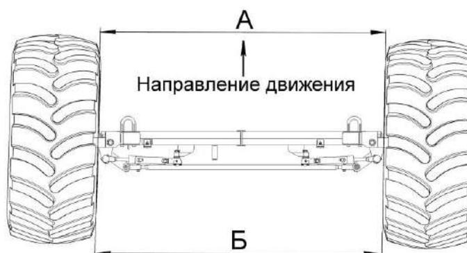
Рисунок 2.39 – Схема регулировки сходимости колес-
