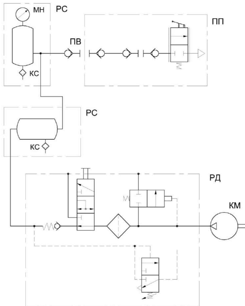
КМ – компрессор; КС – клапан слива конденсата; МН – манометр; ПВ – пневмовывод; ПП – обдувочный пневмопистолет; РС – ресивер; РД – регулятор давления
