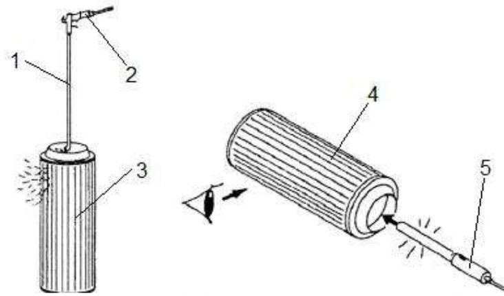
1 – трубка; 2 - пневмопистолет; 3,4 – основной фильтрующий элемент; 5– лампа
