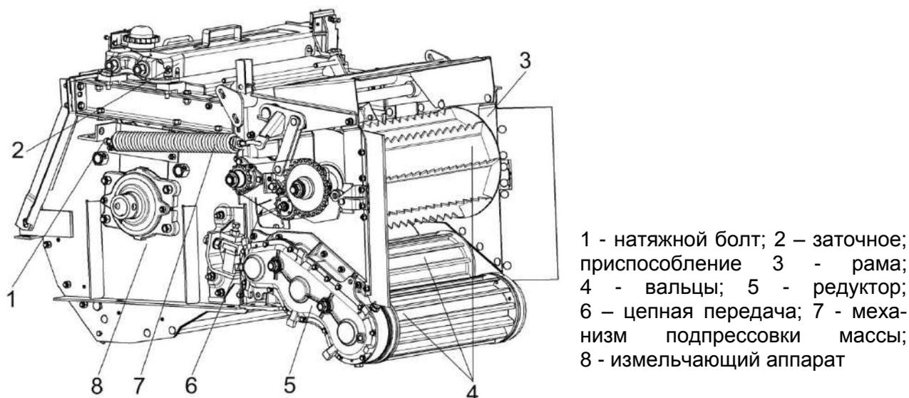
Рисунок 1.6 - Питающе-измельчающий аппарат
