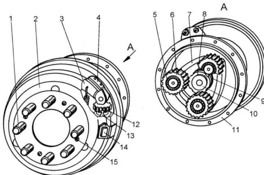
1 - болт крепления колеса; 2 - тормозной барабан; 3 - тормозная колодка; 4 - тормозная накладка; 5 - сферический подшипник; 6 - сателлит; 7 - водило; 8 - гайка; 9 - замочная шайба; 10 - ось; 11 - корпус бортового редуктора; 12 - колпак; 13 - тормозной цилиндр; 14 - крышка; 15 - винт
