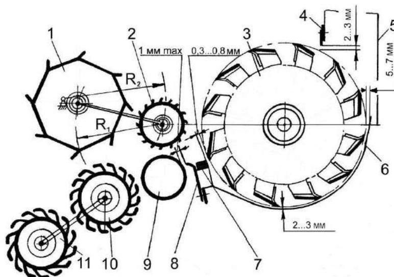
1, 2, 9, 10, 11 - валцы; 3 - измельчающий барабан; 4 - отсекатель; 5 - основание силосопровода; 6 - поддон; 7 - противорежущий брус; 8 – чистик
