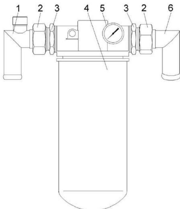
1, 6 – угольники; 2 - гайка; 3 – штуцер; 4 - фильтроэлемент; 5 – манометр
