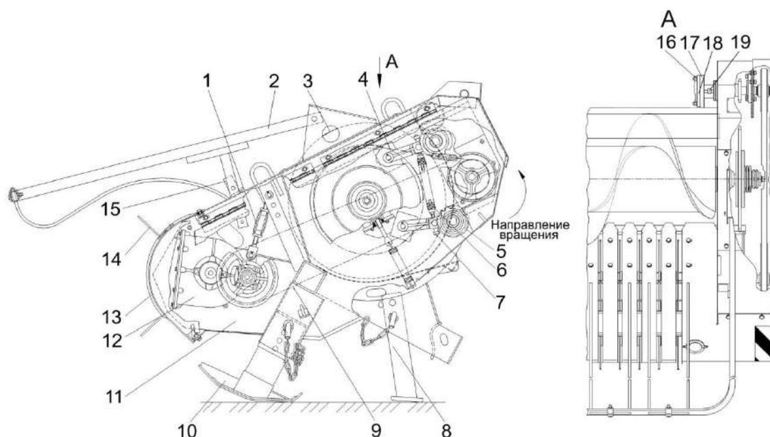
1 – стяжка; 2 – прижимное устройство; 3 – шнек; 4 – цепная передача привода шнека; 5 – натяжной ролик; 6 – пружина; 7 – тяга; 8 – стойка; 9 – клиноременная передача привода подбирающего барабана; 10 – башмак; 11 – рама; 12 – редуктор; 13 – скат; 14 – подбирающее устройство; 15 – упор прижимного устройства; 16 – болт; 17 – корпус; 18 – гидромотор; 19 – соединительная втулка
