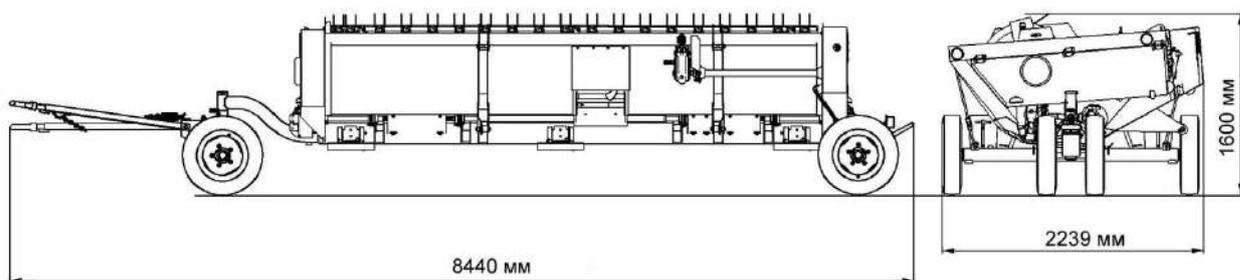
Габаритные размеры жатки для трав на транспортных тележках
