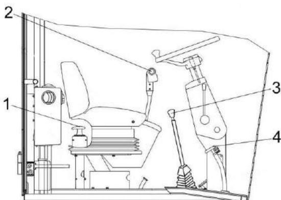
1 – рукоятка стояночного тормоза; 2 – рукоятка управления скоростью движения; 3 – рычаг переключения передач; 4 – педали управления тормозами
