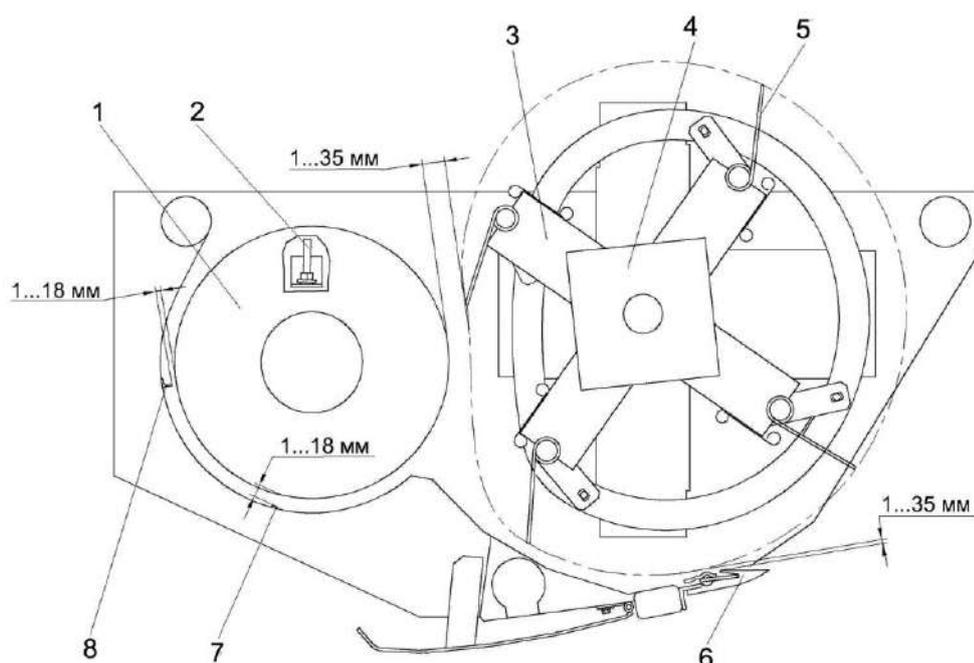
1 – шнек; 2 – болт; 3 – мотовило; 4 – опора мотовила; 5 – пружинный зуб; 6 – палец режущего аппарата; 7 – нижний чистик; 8 – уголковый чистик
