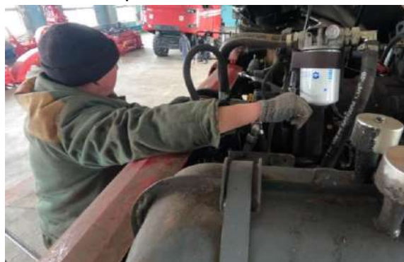
Рисунок 3.13 – Вид на демонтаж всасывающего фильтроэлемента с использованием ключа фильтра
