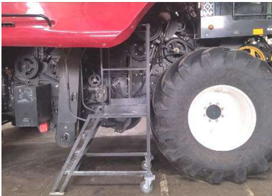
Рисунок 3.3 – Лестница с площадкой для заправки насоса АЦСС
