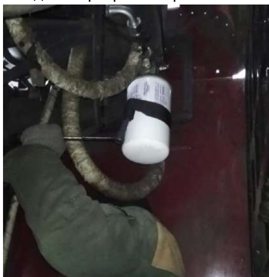
Рисунок 3.10 – Вид на сливной фильтроэлемент, демонтируемый при помощи ключа фильтра
