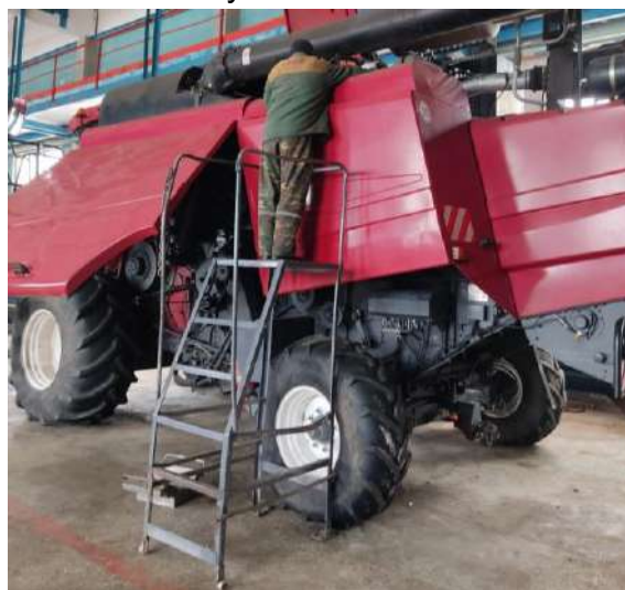
Рисунок 3.12 – Вид на лестничную площадку с механизатором при замене всасывающего фильтроэлемента
