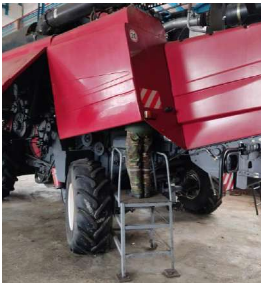
Рисунок 3.8 – Вид на лестничную площадку с механизатором при замене сливного и напорного фильтроэлементов
