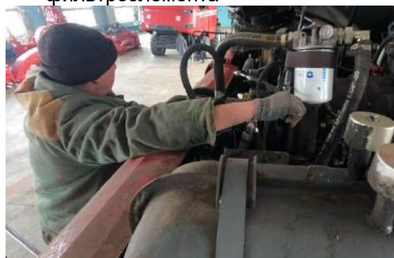
Рисунок 3.13 – Вид на демонтаж всасывающего фильтроэлемента с использованием ключа фильтра
