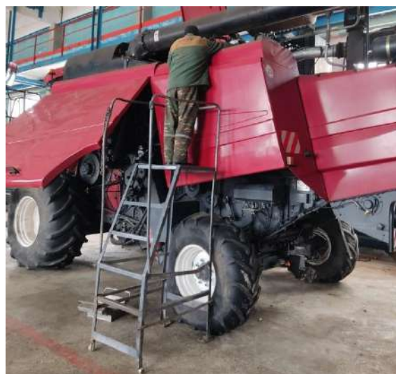
Рисунок 3.12 – Вид на лестничную площадку с оператором при замене всасывающего фильтроэлемента
