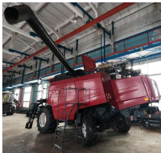
Рисунок 3.11 – Вид на трубу выгрузного шнека повернутую на угол не менее 50°
