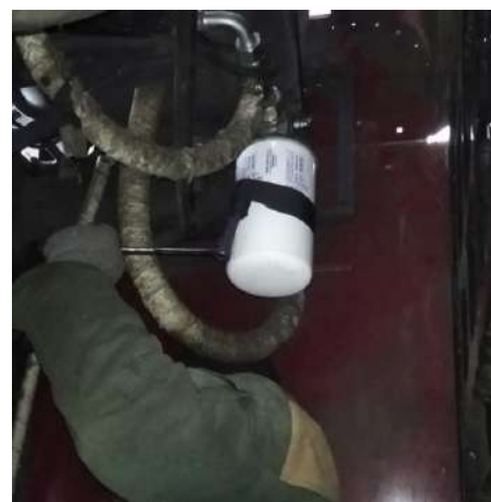
Рисунок 3.9 – Сливной фильтроэлемент, демонтируемый при помощи ключа фильтра
