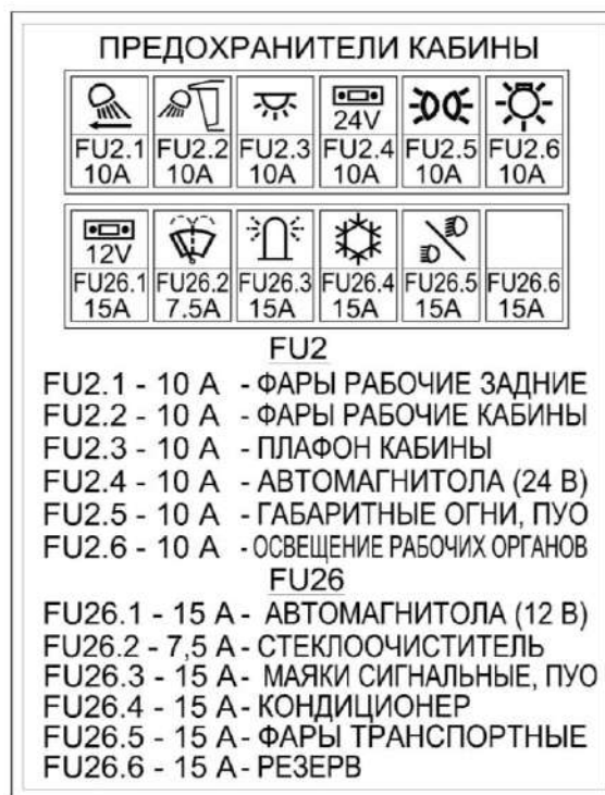
Рисунок 1.37 – Схема расположения предохранителей
