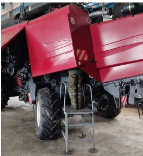
Рисунок 3.7 – Вид на лестничную площадку с оператором при замене сливного и напорного фильтроэлементов
