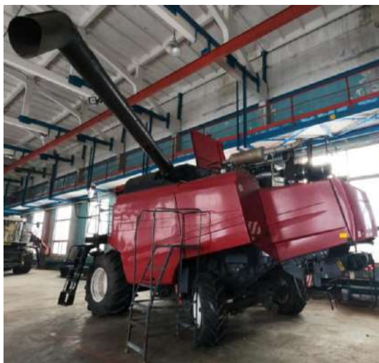
Рисунок 3.15 – Вид на трубу выгрузного шнека повернутую на угол не менее 50°
