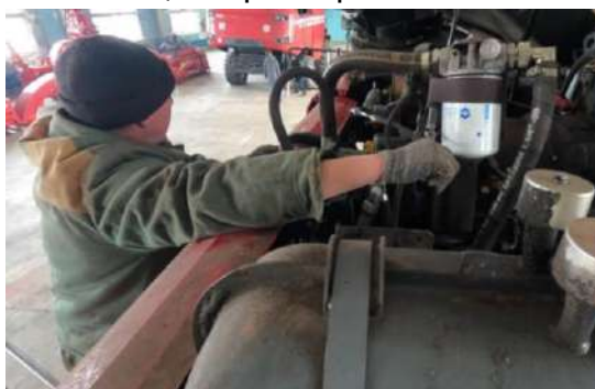
Рисунок 3.17 – Вид на демонтаж всасывающего фильтроэлемента с использованием ключа фильтра
