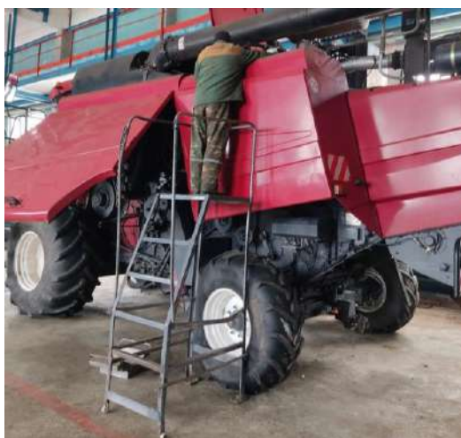
Рисунок 3.16 – Вид на лестничную площадку с механизатором при замене всасывающего фильтроэлемента
