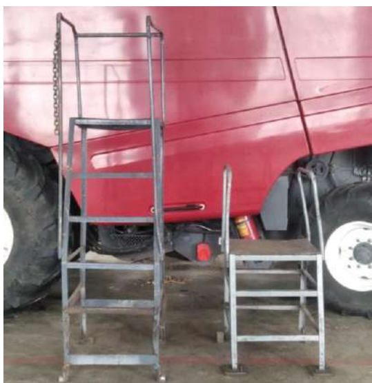
Рисунок 3.10 – Вид на лестницы с площадкой
