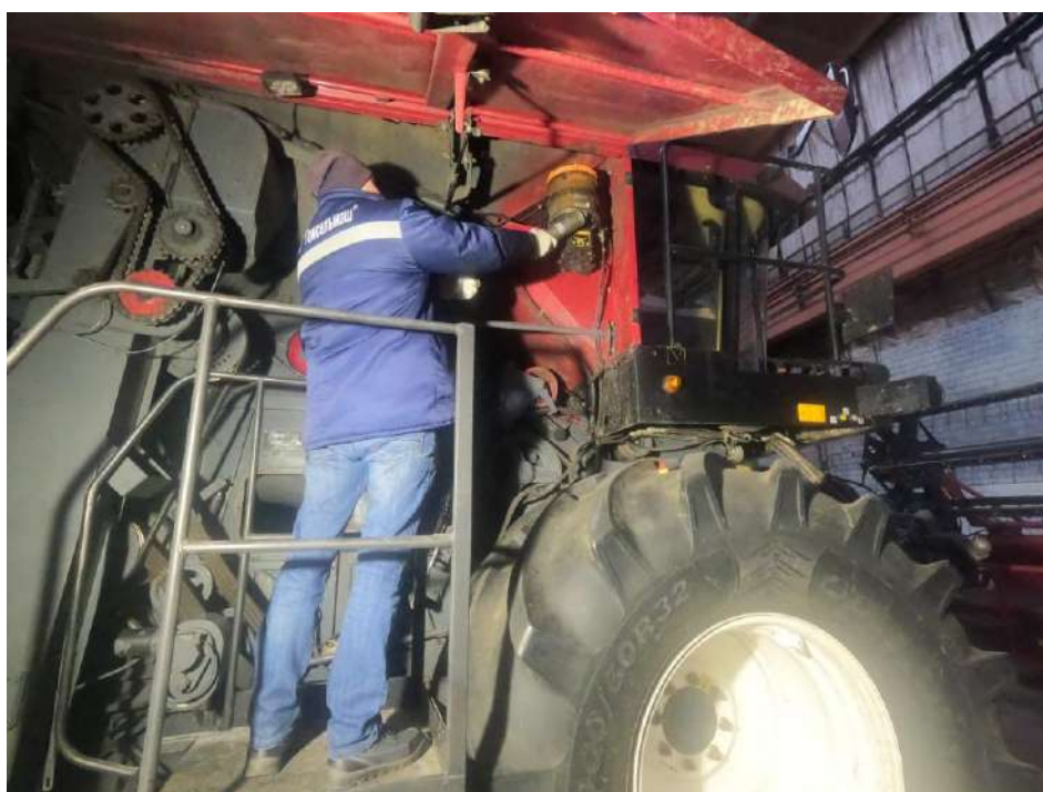
Рисунок 3.6 – Лестница с площадкой для заправки насоса АЦСС
