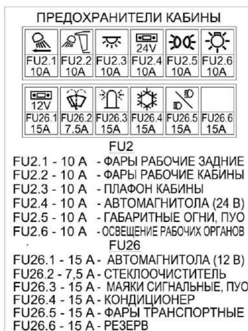
Рисунок 1.40 – Схема расположения предохранителей
