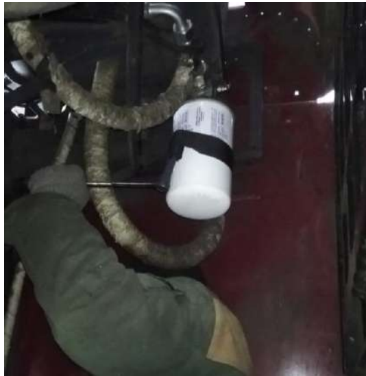
Рисунок 3.14 – Вид на сливной фильтроэлемент, демонтируемый при помощи ключа фильтра
