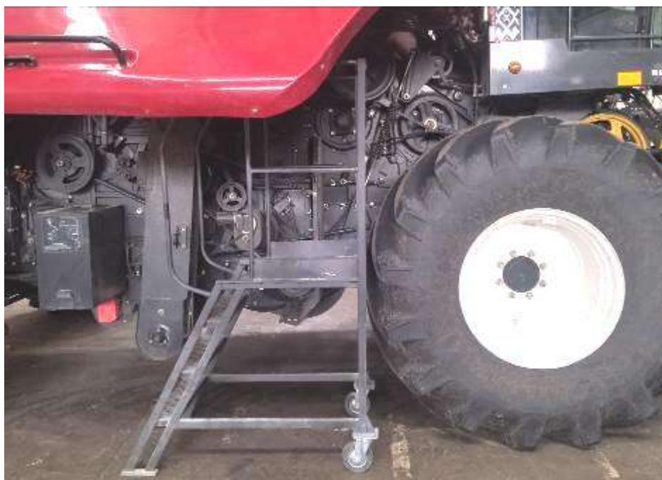
Рисунок 3.6 – Лестница с площадкой для заправки насоса АЦСС
