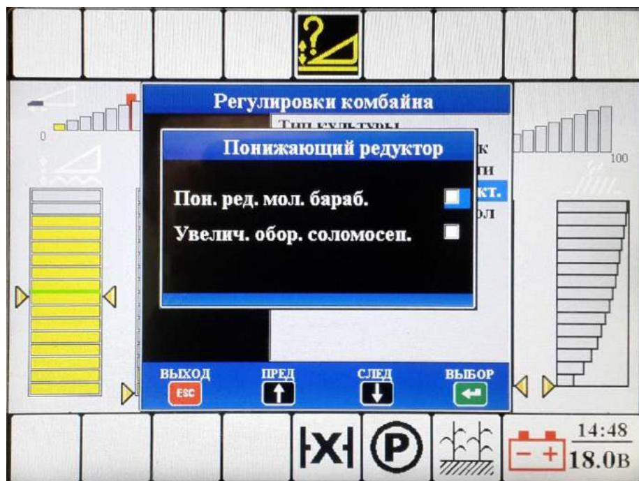
Рисунок Ж. 8 – Вид окна «Установить понижающий редуктор»
