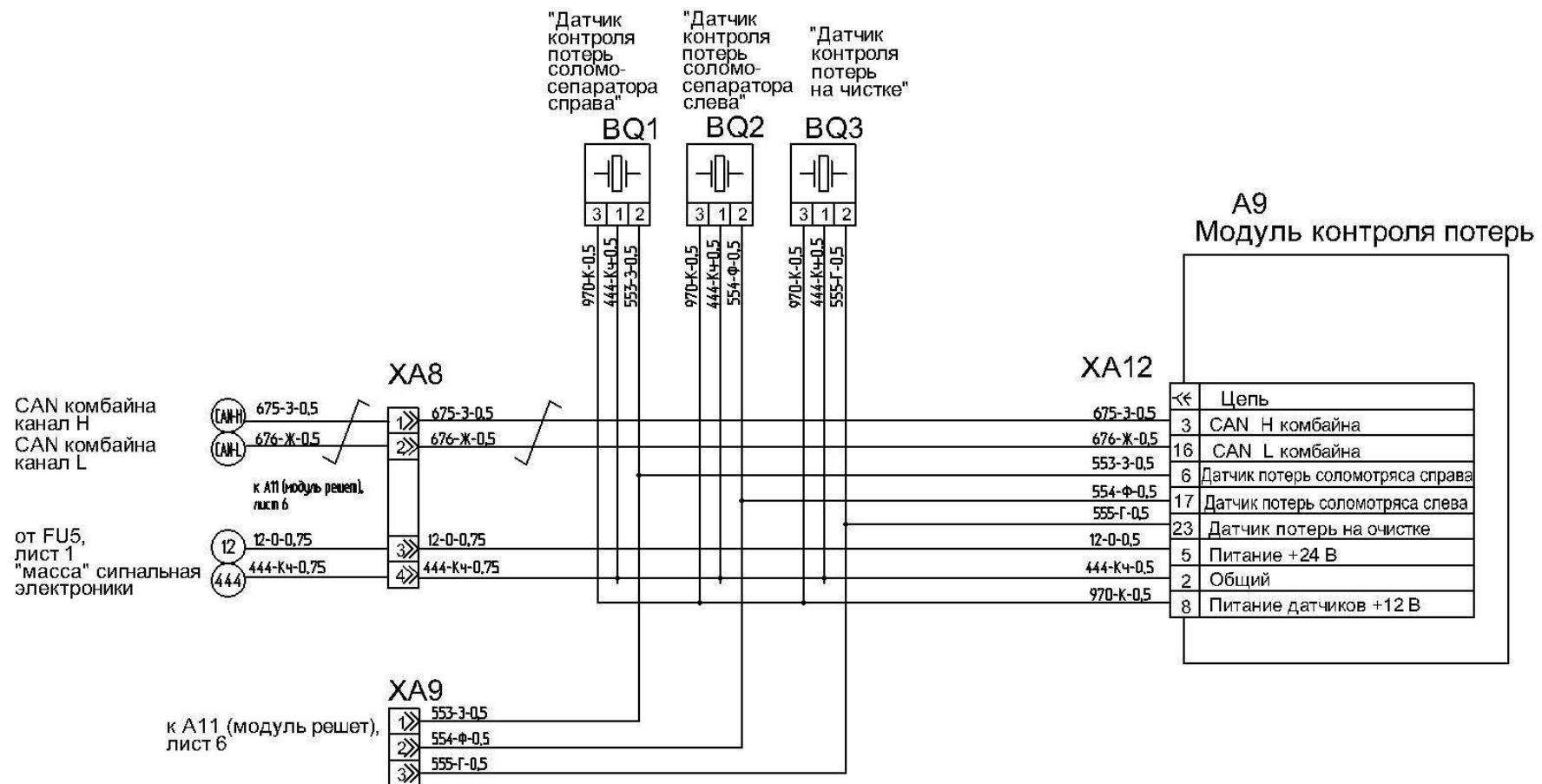
Рисунок Б.10 – Схема электрическая принципиальная комбайна (лист 10)
