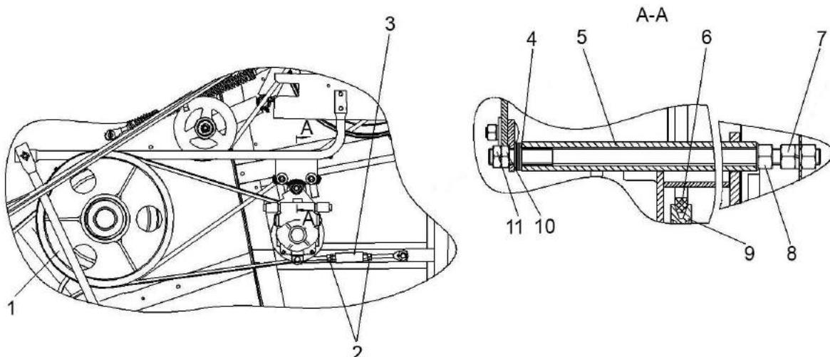
1, 9 – шкивы; 2 - контргайки; 3 – стяжка; 4 – набор шайб; 5 – рычаг; 6 – ремень; 7, 8, 10, 11 – гайка;
