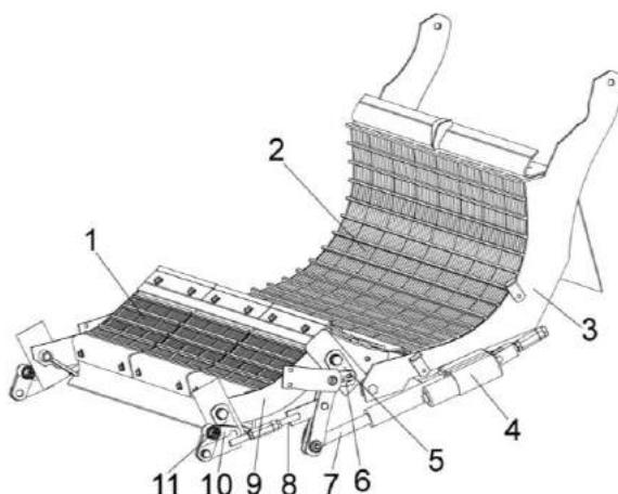
1 – переднее подбарабанье; 2 – заднее подбарабанье; 3 – каркас заднего подбарабанья; 4 - электромеханизм; 5, 11 - стяжки; 6, 10 – рычаги; 7, 8 – тяги; 9 – каркас переднего подбарабанья
