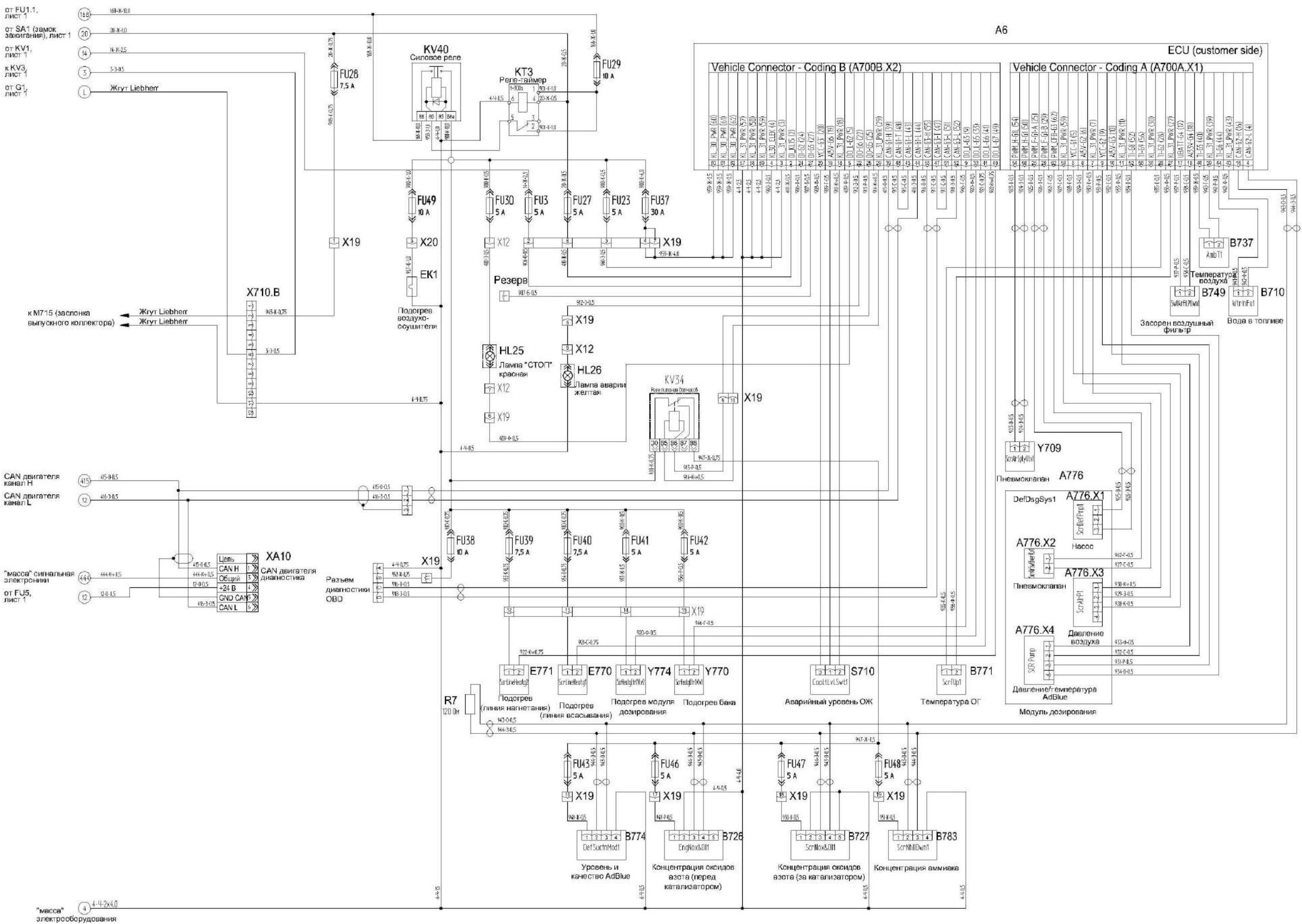
Рисунок Б.8 – Схема электрическая принципиальная комбайна (лист 8)
