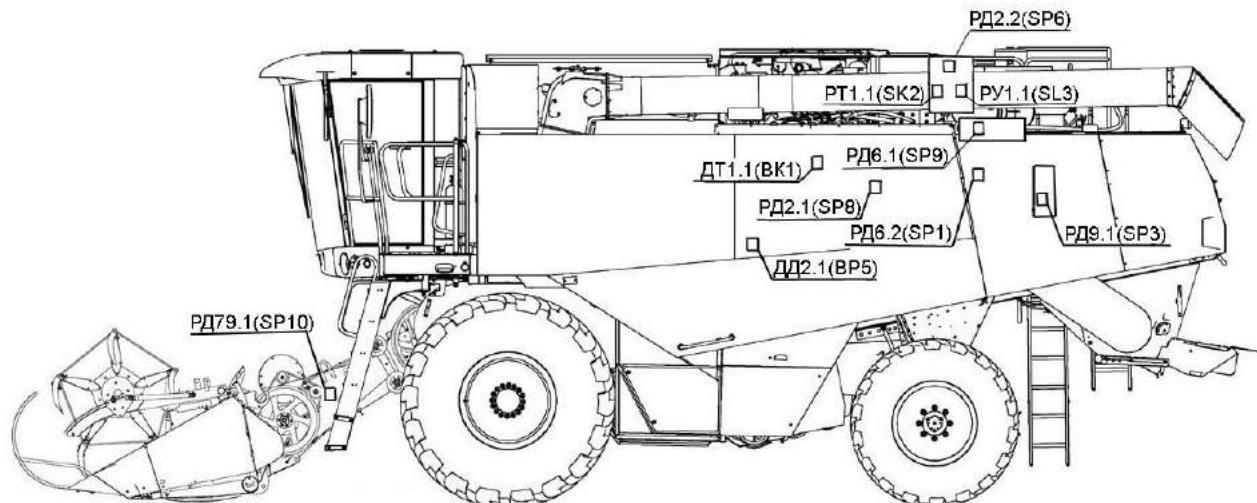
РД - реле давления; РУ - реле уровня; ДД - датчик давления; РТ - реле температуры;
