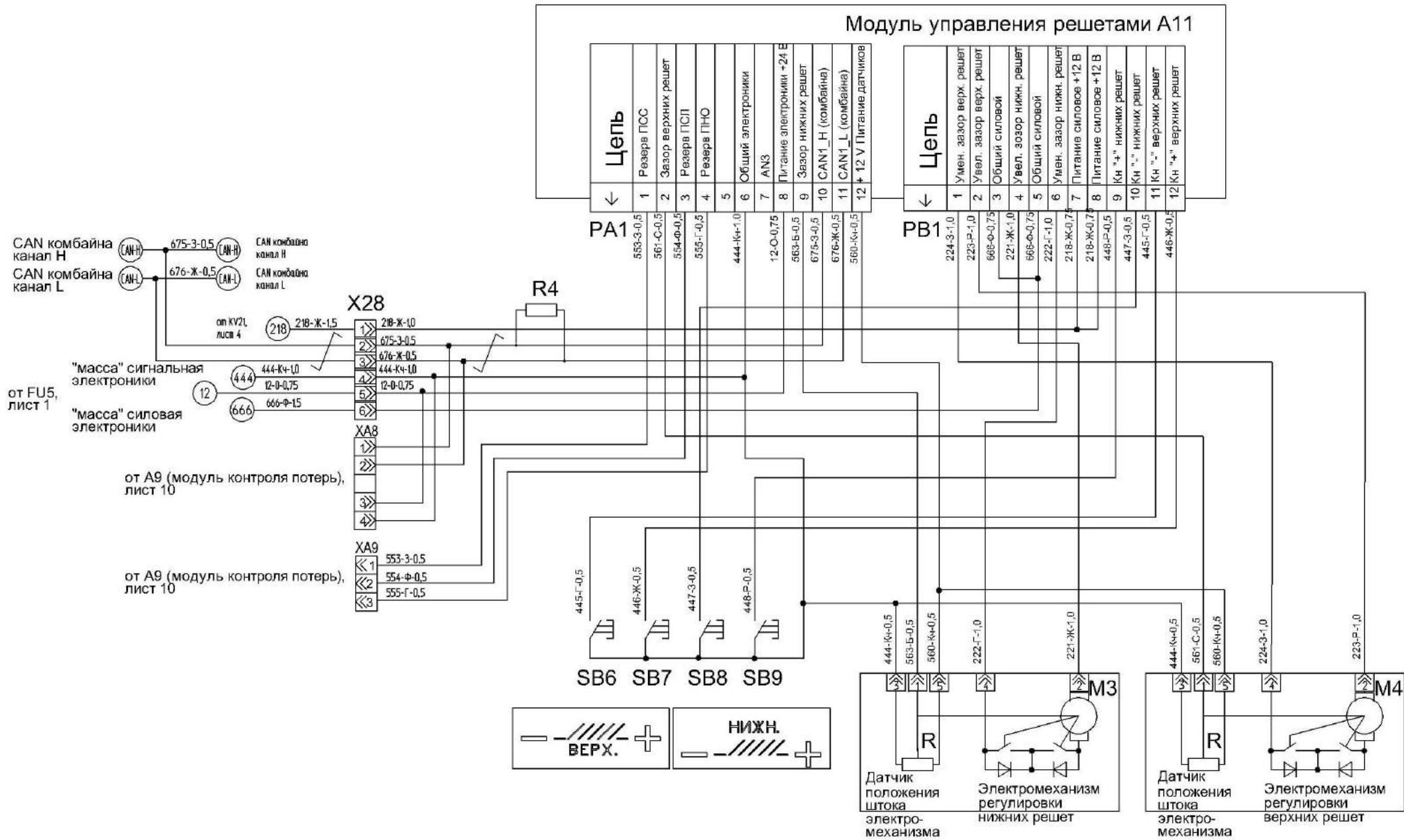
Рисунок Б.6 – Схема электрическая принципиальная комбайна (лист 6)
