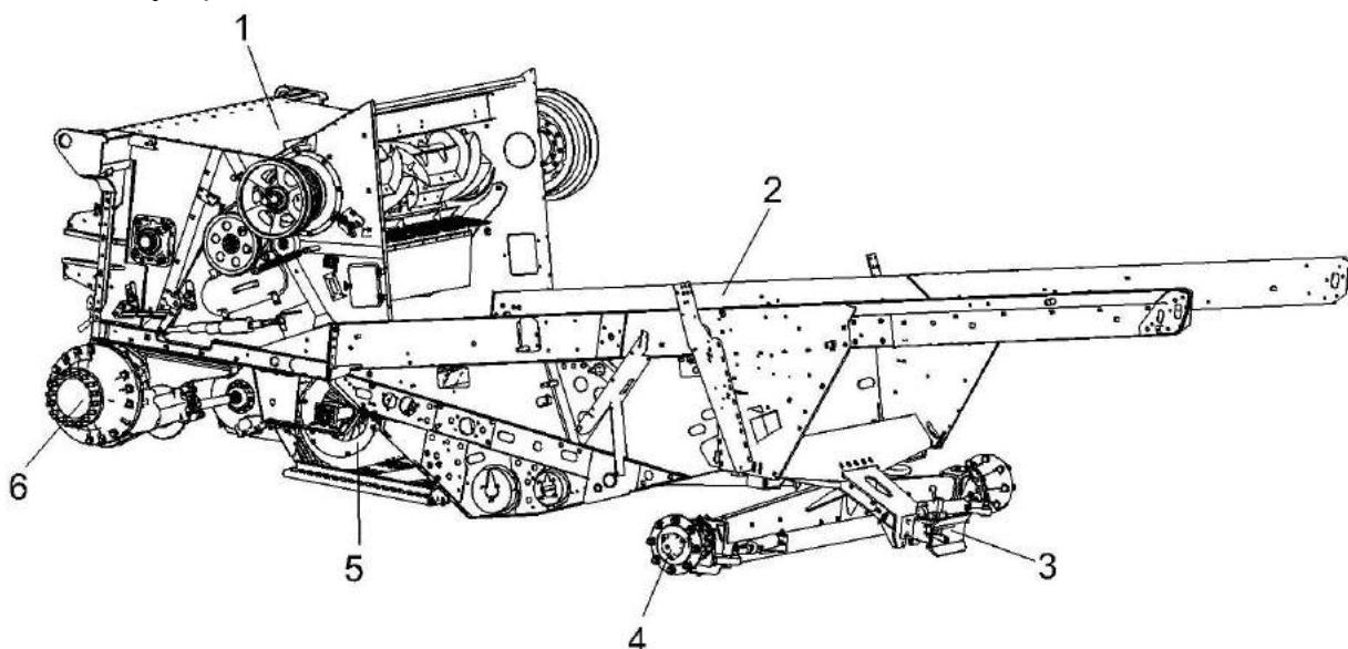
1 – аппарат молотильный; 2 – рама; 3 - устройство тягово-цепное; 4 – мост управляемых колес; 5 - установка вентилятора очистки; 6 – мост ведущих колес;
