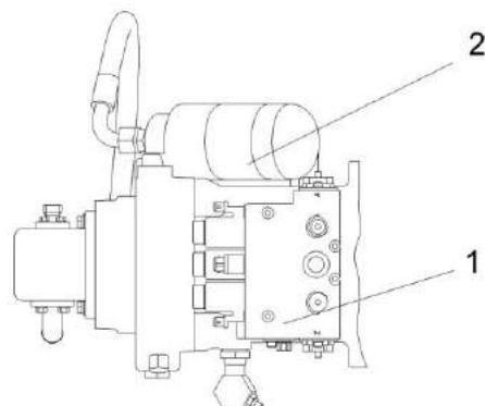
1 – гидронасос; 2 – фильтроэлемент
