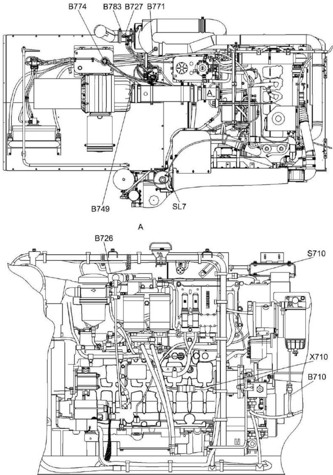
B774 - датчик уровня и качества Adblue; B783 - датчик концентрации аммиака; B727 - датчик концентрации оксидов азота (после катализации); B771 - датчик температуры отработавших газов; B749 - датчик засоренности воздушного фильтра; SL7 - датчик аварийного уровня масла (бак вентилятора); B726 - датчик концентрации оксидов азота (перед катализатором); S710 - датчик аварийного уровня охлаждающей жидкости; X710 - соединение со жгутом двигателя; B710 - датчик наличия воды в топливе
