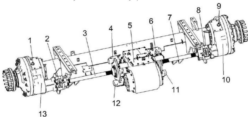
1, 9 – сапуны; 2, 8 – плавающие скобы с энергоаккумулятором; 3, 7 – полуоси; 4, 6 – механизм тормозной верхний, 5 – коробка передач; 10, 13 – бортовые редукторы; 11, 12 - механизм тормозной нижний
