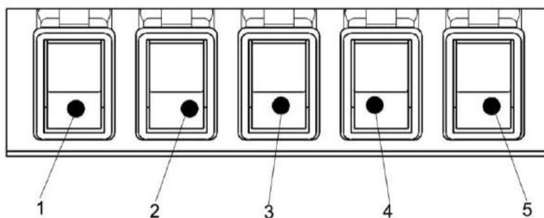
1 – выключатель габаритных огней; 2 – выключатель проблесковых маяков; 3 – выключатель передних рабочих фар кабины; 4 – выключатель задних рабочих фар; 5 – выключатель фары выгрузного шнека
