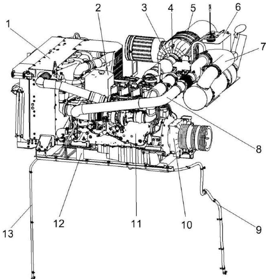
1 – установка радиатора; 2 – бачок расширительный; 3 – индикатор засорения; 4 - датчик давления; 5 – фильтр воздушный; 6 - бак AdBlue; 7 - смеситель выхлопных газов; 8 - установка выпускной системы; 9 - рукав сливной масла из картера двигателя; 10 - мультиплликатор; 11 – двигатель; 12 – рама подмоторная; 13 - рукав сливной охлаждающей жидкости
