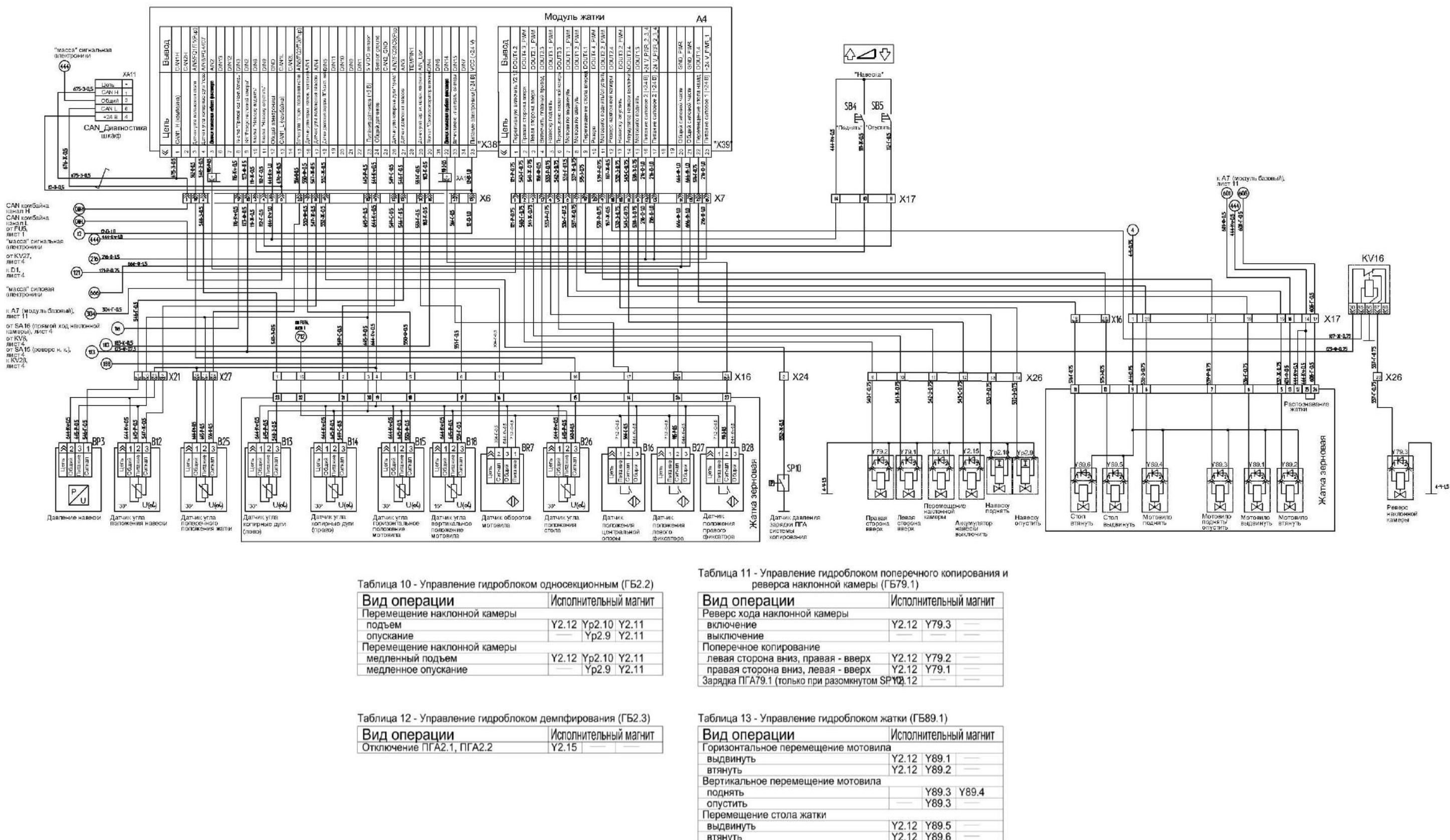
Рисунок Б.9 – Схема электрическая принципиальная комбайна (лист 9)
