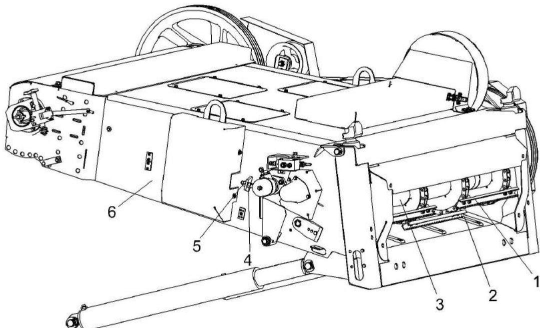
1 – транспортер; 2 – успокоитель; 3 – вал нижний; 4, 5 – гайки; 6 – рама
