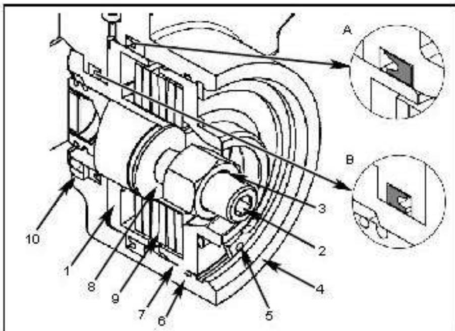
Замена уплотнений производится в соответствии с нижеприведенной инструкцией:
