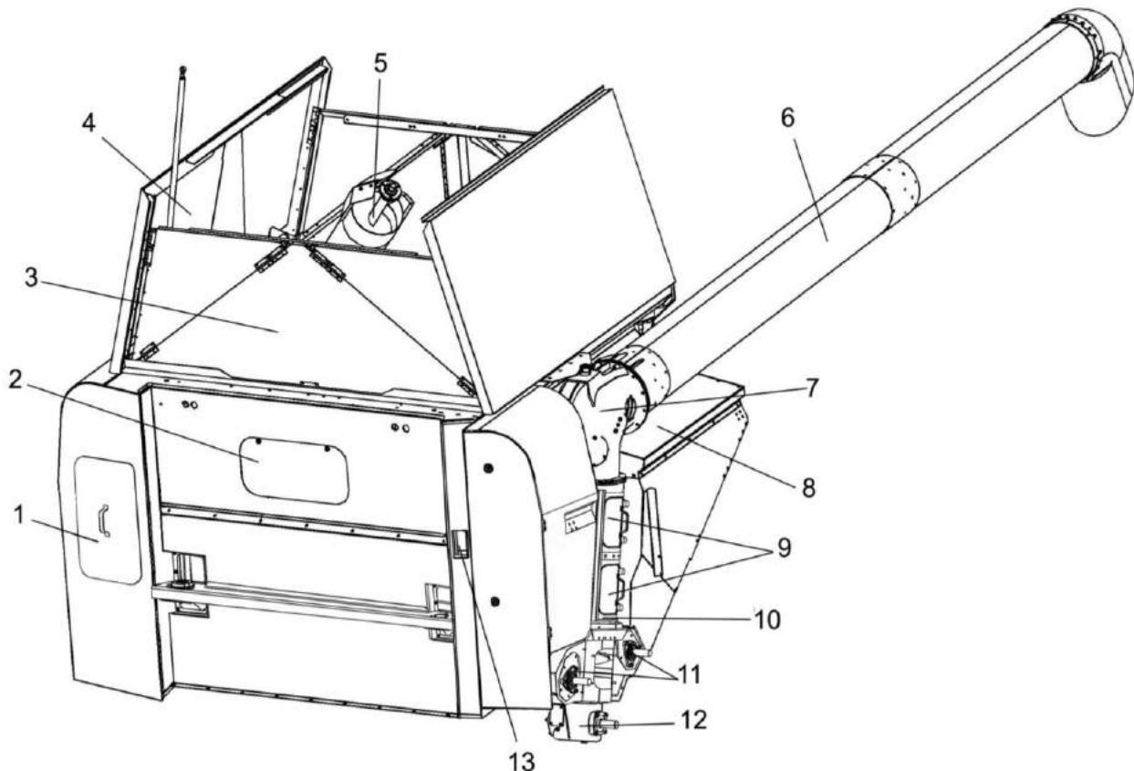
1 – крышка лаза в бункер; 2 - смотровое окно; 3 - надставка бункера; 4 - крыша бункера; 5 – шнек загрузной; 6 - шнек поворотный выгрузной; 7 - отвод с редуктором; 8 – настил; 9 - крышки; 10 – шнек наклонный выгрузной; 11 – шнеки горизонтальные; 12 – редуктор; 13 - окно пробоотборника
