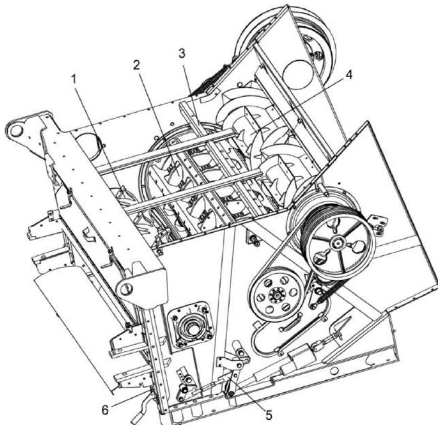
1 – барабан ускоряющий; 2 – барабан молотильный; 3 - бич; 4 – отбойный битер; 5 – подвески подбарабанья; 6 - камнеуловитель
