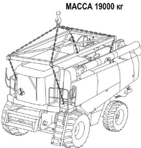
Рисунок 6.1 – Схема строповки молотилки самоходной
