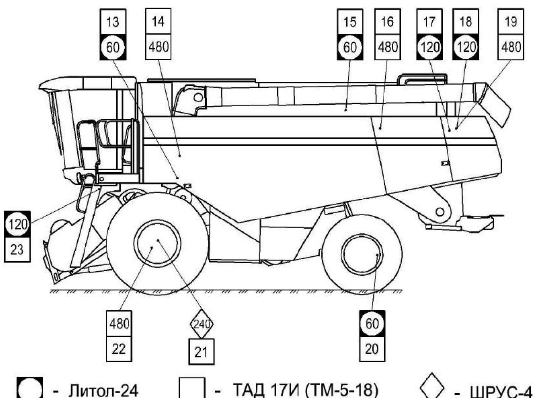
Рисунок 3.2 – Смазка молотилки самоходной (вид слева)
