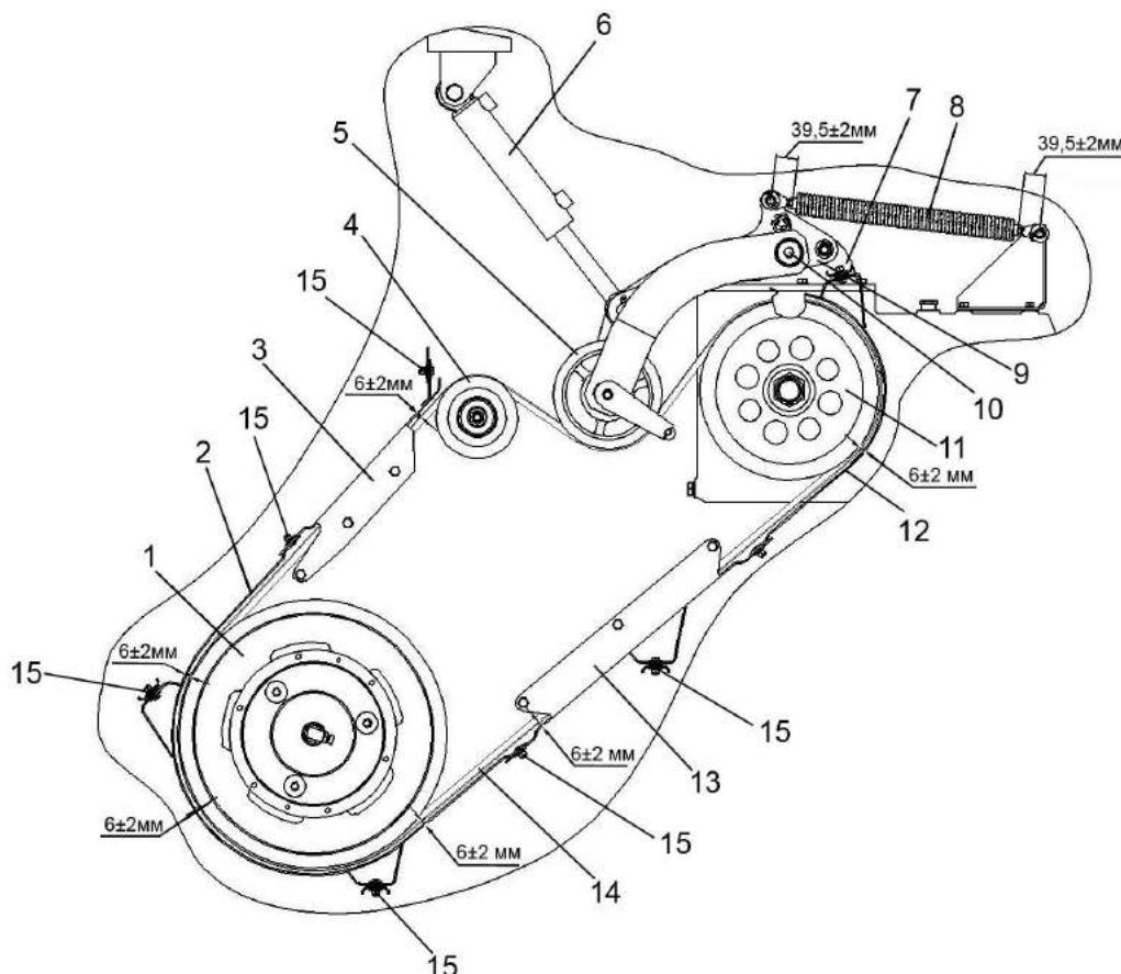
1, 11 – шкивы; 2, 3, 12, 13 – ограждение; 4 – ролик обводной; 5 – ролик; 6 – гидроцилиндр главного привода; 7 – опора; 8 – пружина; 9 – рычаг; 10 – ось; 14 – ремень; 15 - шайбы
