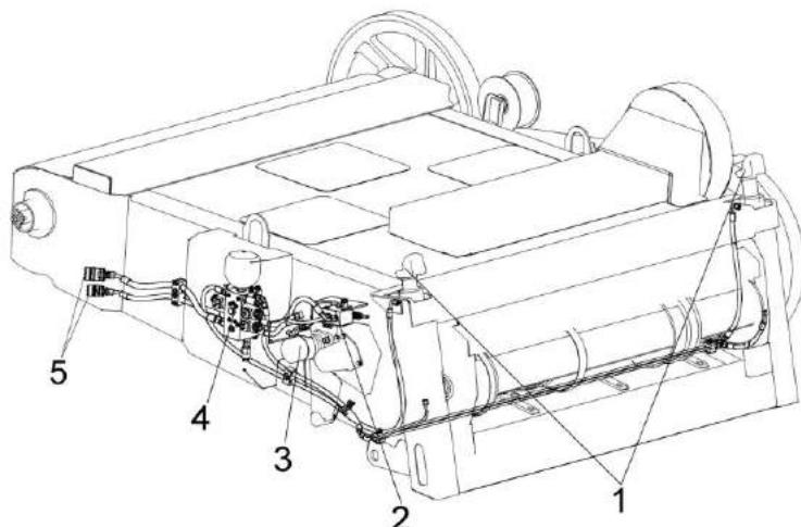
1 – гидроцилиндры поперечного копирования; 2 – гидроцилиндр включения реверса; 3 - гидромотор реверса; 4 – гидроблок поперечного копирования и реверса; 5 - муфты быстрого соединения
