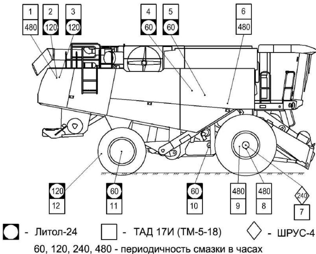
Рисунок 3.1 – Смазка молотилки самоходной (вид справа)
