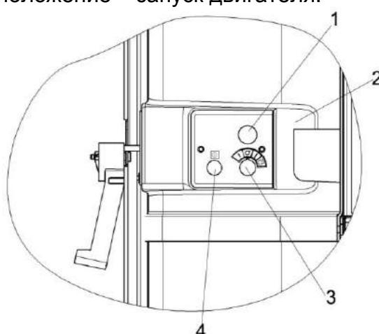
1 – розетка бортовой сети; 2 – стойка кабины; 3 – замок зажигания; 4 – выключатель кнопочный включения ПИТАНИЯ
