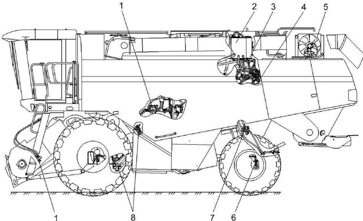
1 – гидросистема привода мотовила жатки; 2 – бак масляный; 3 – гидросистема привода стояночного тормоза; 4 – гидросистема низкого давления; 5 - гидросистема привода радиатора; 6 - гидросистема рулевого управления и силовых гидроцилиндров; 7 - гидросистема привода половоразбрасывателя; 8 - гидросистема привода ходовой части
