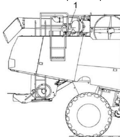
1 – крышка заливной горловины топливного бака
