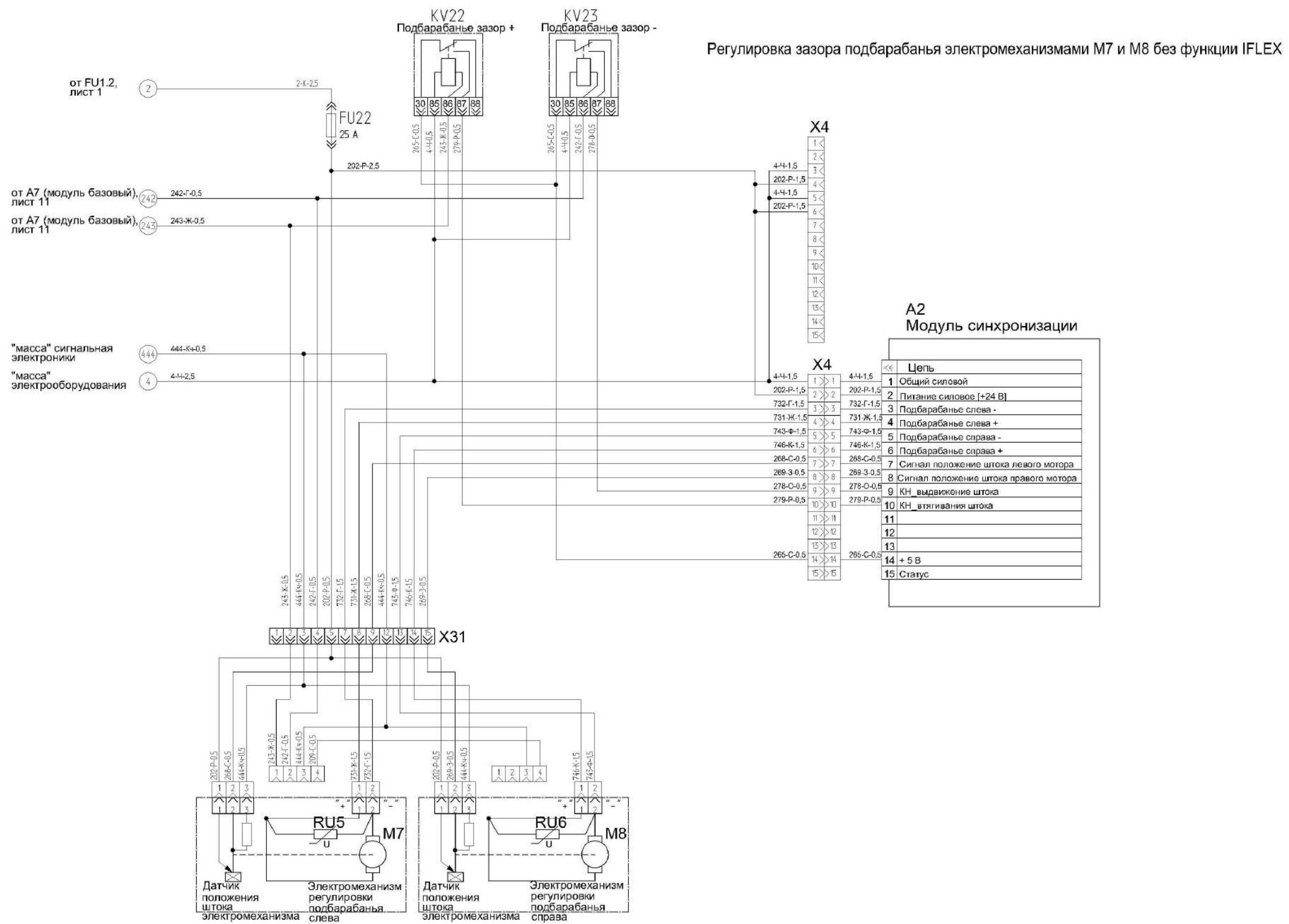
Рисунок Б.12 – Схема электрическая принципиальная комбайна (лист 12)
