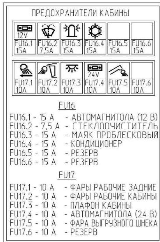
Рисунок 1.43 – Схема расположения предохранителей
