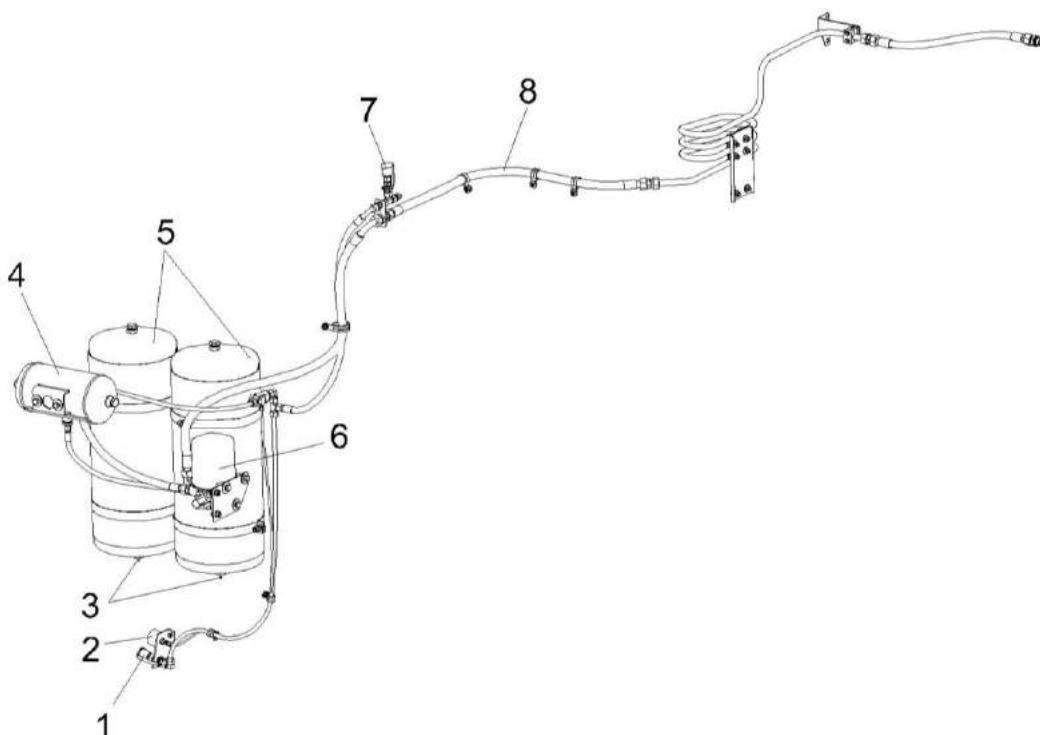
1, 7 – пневмовывод; 2 - манометр; 3 – клапан слива конденсата; 4 - ресивер регенерации; 5 – ресивер; 6 - регулятор давления с осушителем; 8 – трубопровод
