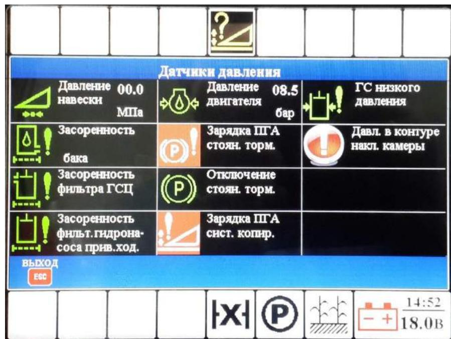
Рисунок Ж. 33 – Вид окна «Датчики давления»
