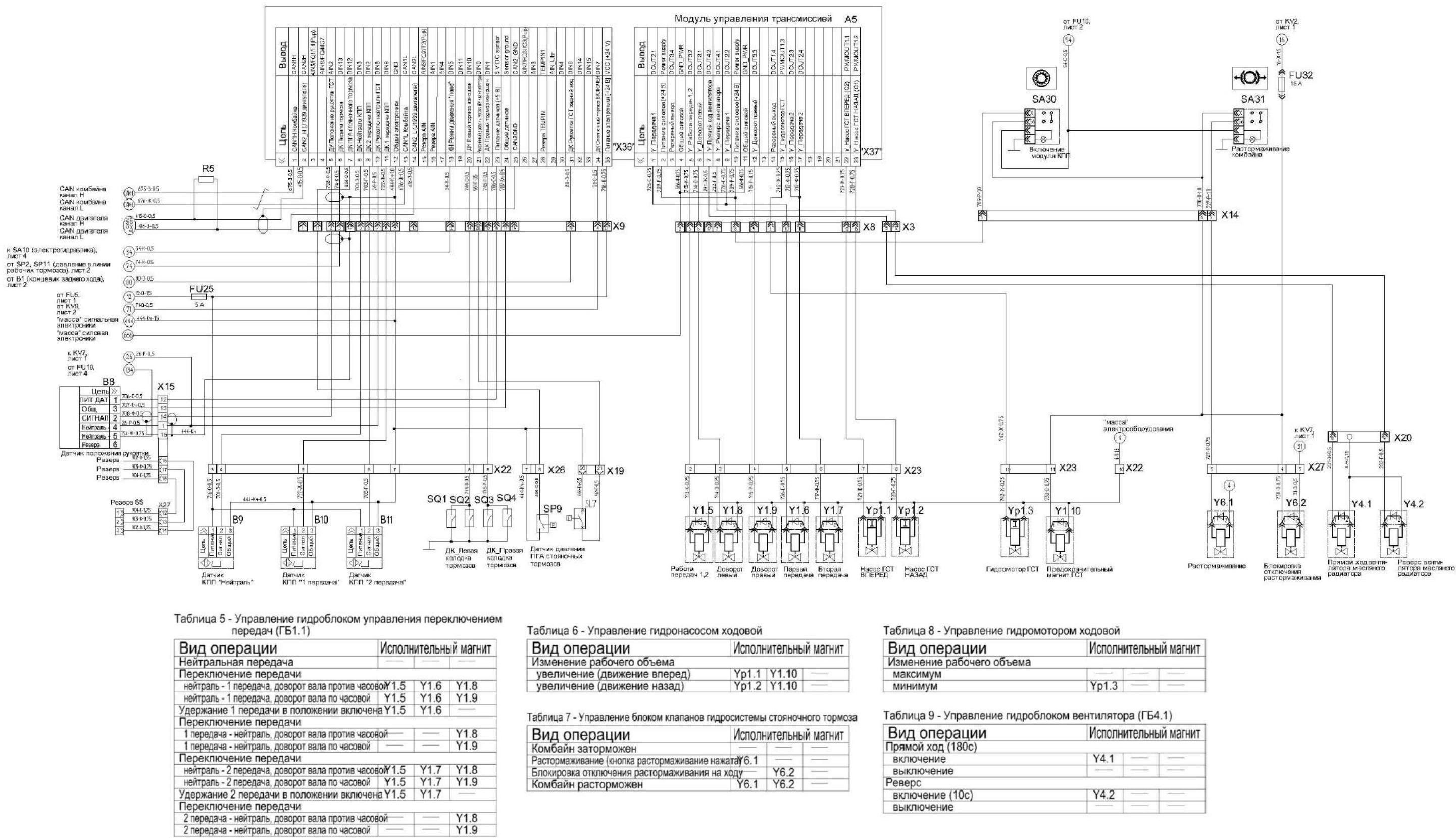
Рисунок Б.7 – Схема электрическая принципиальная комбайна (лист 7)
