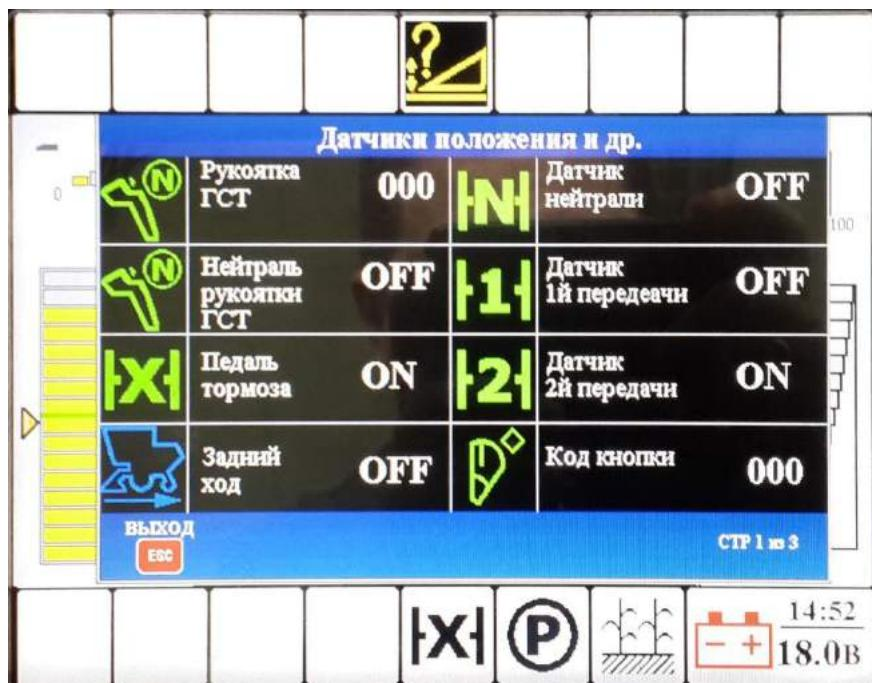
Рисунок Ж. 35 – Вид окна «Датчики положения»
