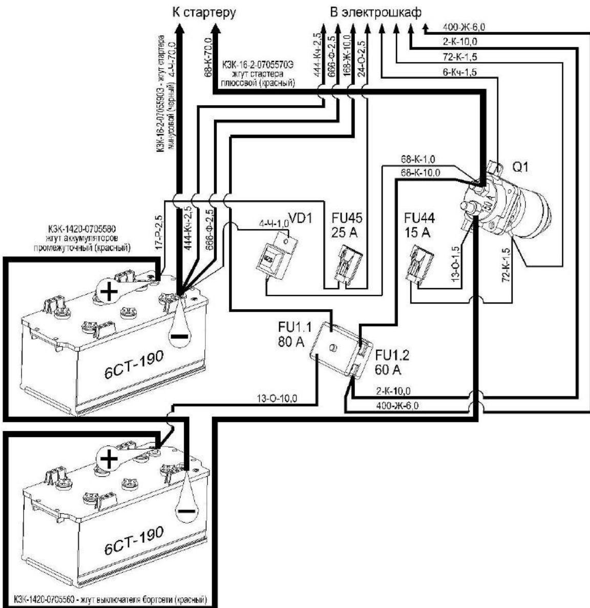
FU1.1 (80 A) – предохранитель защиты силового реле (перегорает при коротком замыкании или при механическом повреждении жгута питания на участке ящик АКБ–электрошкапа);
