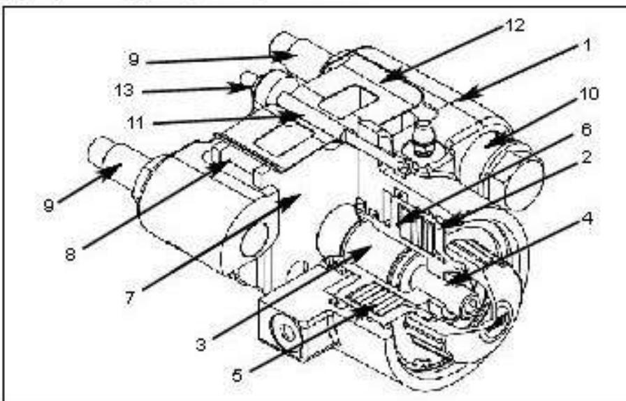
В данном тормозе две идентичные тормозные колодки перемещаются по направляющим плоскостям, расположенным в верхней части корпуса и поддерживаются пружинной пластиной 12. Тормоз прикрепляется непосредственно на коробку передач или корпус моста посредством направляющих пальцев 9, по которым он может свободно перемещаться.
