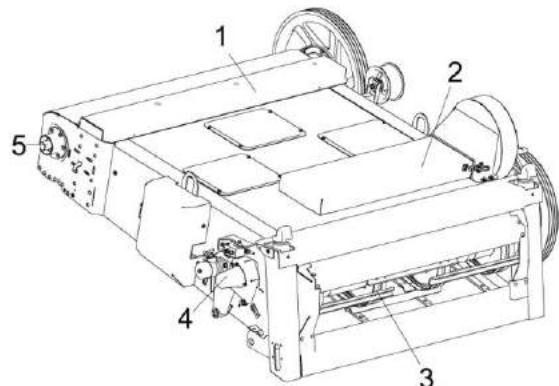
1 – рама; 2 – вентилятор; 3 – цепочно – планчатор; 4 – механизм реверса; 5 – вал верхний; 6 – цепочка; 7 – упор; 8- вал
