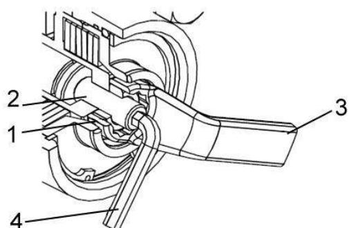
1 – контргайка; 2 – регулировочный болт;
