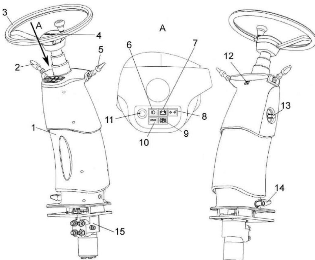
1 – корпус; 2 – переключатель указателей поворотов и света; 3 – рулевое колесо; 4 – зажим; 5 – переключатель стеклоочистителей; 6 – контрольная лампа дальнего света; 7 – контрольная лампа зарядки АКБ; 8 – контрольная лампа указателей поворотов; 9 – контрольная лампа стояночного тормоза; 10 – контрольная лампа сигнализации аварийных режимов «СТОП»; 11 – выключатель звукового сигнала; 12 – выключатель аварийной сигнализации; 13, 14 – зажимы рулевой колонки; 15 – насос-дозатор
