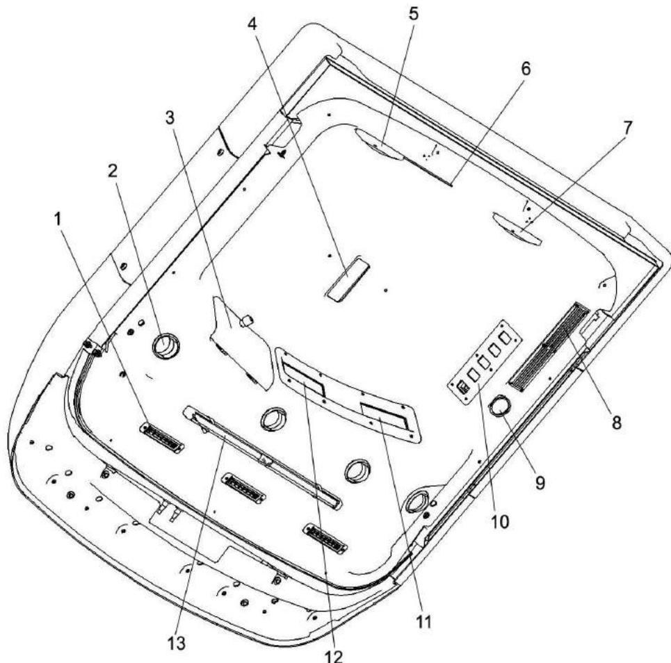
1, 2 – дефлекторы; 3 – крышка охлаждаемого бокса; 4 – плафон освещения кабины; 5, 7 – динамики автомагнитолы; 6 – панель блока предохранителей; 8 – решетка фильтра рециркуляции воздуха; 9 – плафон индивидуального освещения; 10 – панель выключателей; 11 – панель управления кондиционером; 12 – автомагнитола; 13 – шторка солнцезащитная
