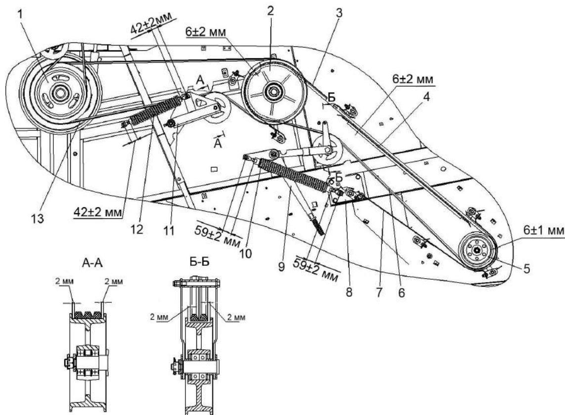
1, 2, 5 – шкивы; 3, 4, 7 - щитки; 6, 13 – ремни; 8 - опора; 9 – натяжник; 10, 12 – пружина; 11 - рычаг
