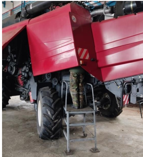
Рисунок 3.11 – Вид на лестничную площадку с оператором при замене фильтроэлементов сливного и напорного фильтров
