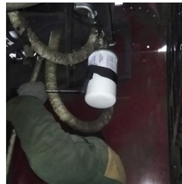
Рисунок 3.13 – Фильтроэлемент сливного фильтра, демонтируемый при помощи ключа фильтра
