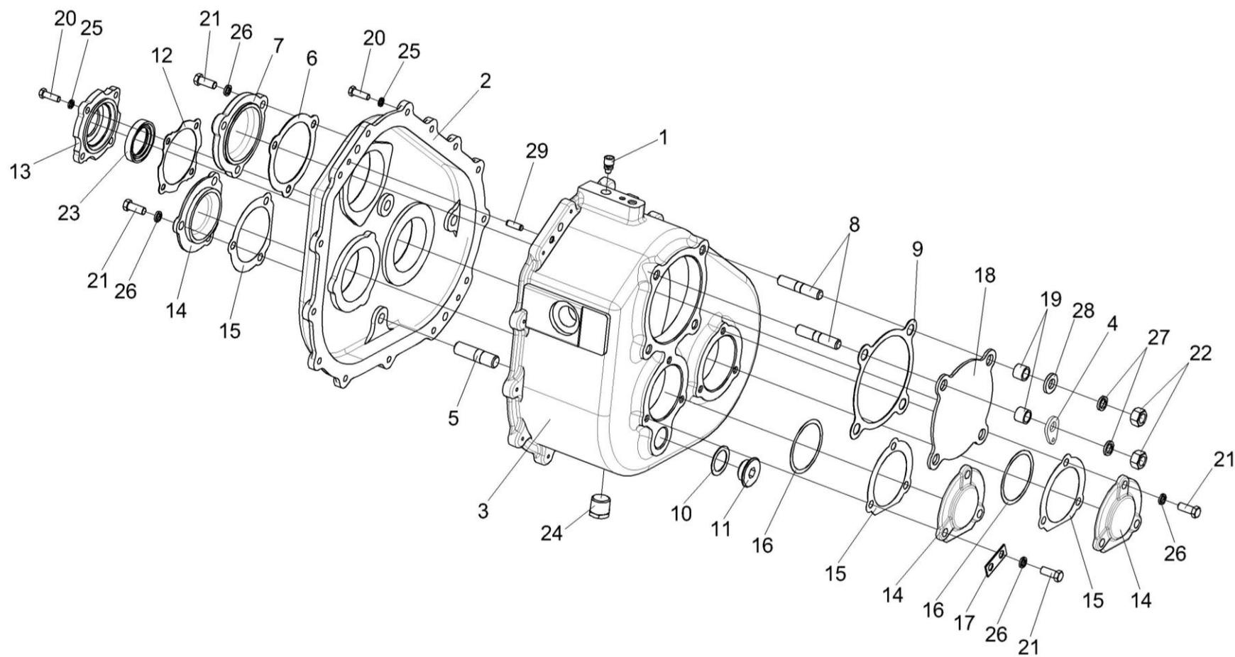
Рисунок 19 – Коробка передач KBC-2-0114100A. Корпуса и крышки
