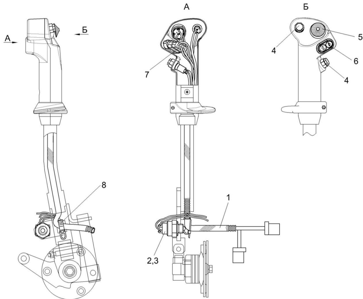
Рисунок 127 – Установка электрооборудования привода КВС-5-0724000
