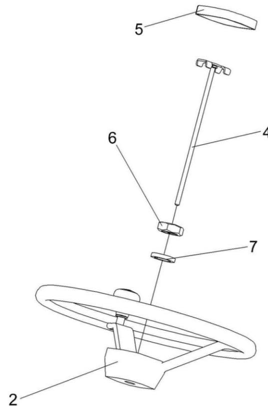
Рисунок 135 – Установка колеса рулевого КЗК-12-0122600 или КЗК-12-0122600-01
