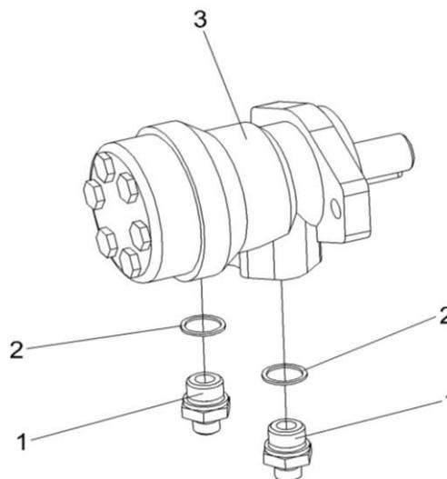
Рисунок 61 – Гидромотор силосопровода КВС-1-0602970
