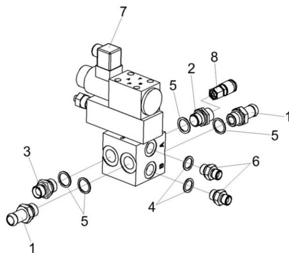
Рисунок 201 – Гидроблок воздухозаборника КВС-5-0602310А
