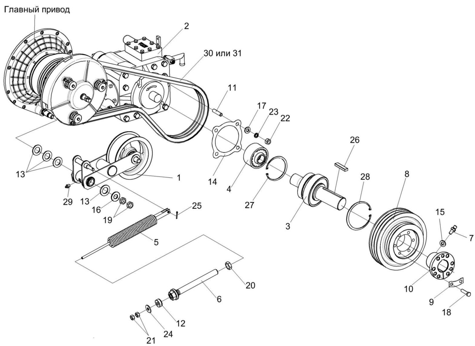
Рисунок 87 – Привод гидростата КВС-2-0133000
