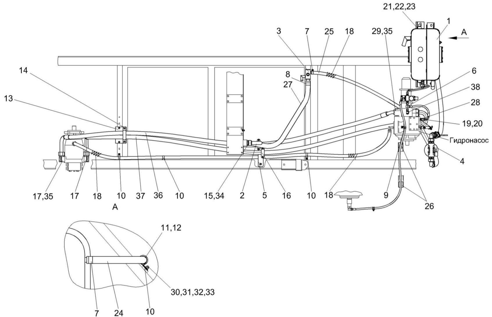
Рисунок 185 – Гидросистема привода ходовой части КВС-2-0601000В (вид сверху)
