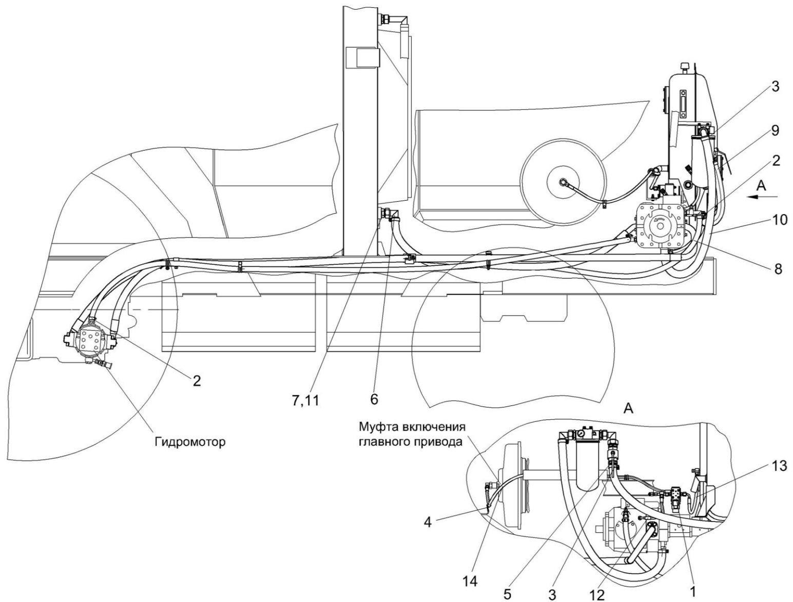
Рисунок 184 – Гидросистема привода ходовой части КВС-2-0601000В (вид слева)
