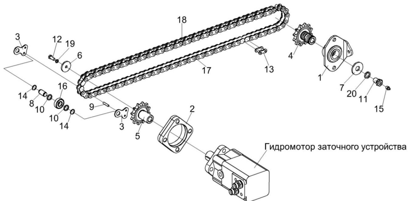
Рисунок 32 – Привод каретки KBC-2-0116510
