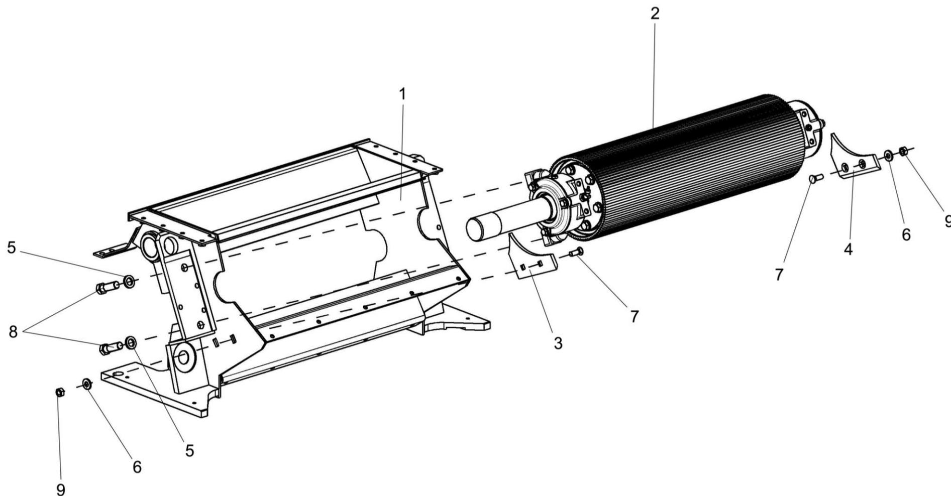
Рисунок 44 – Устройство доизмельчающее КВС-1-0148310 (установка верхнего вальца)
