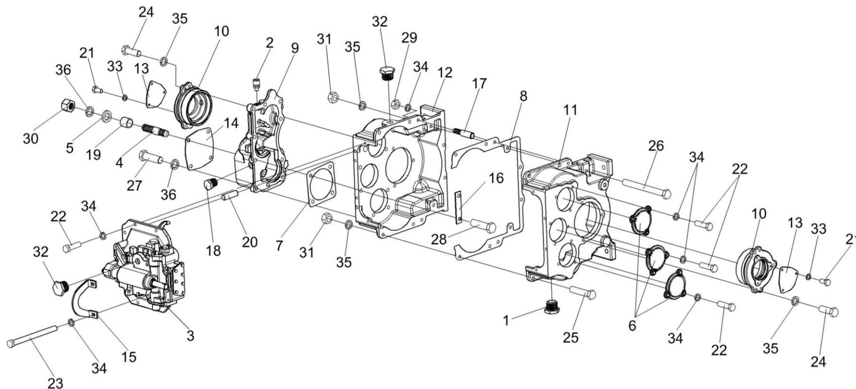
Рисунок 109 – Коробка диапазонов 3518020-46150 (корпус, крышки)
