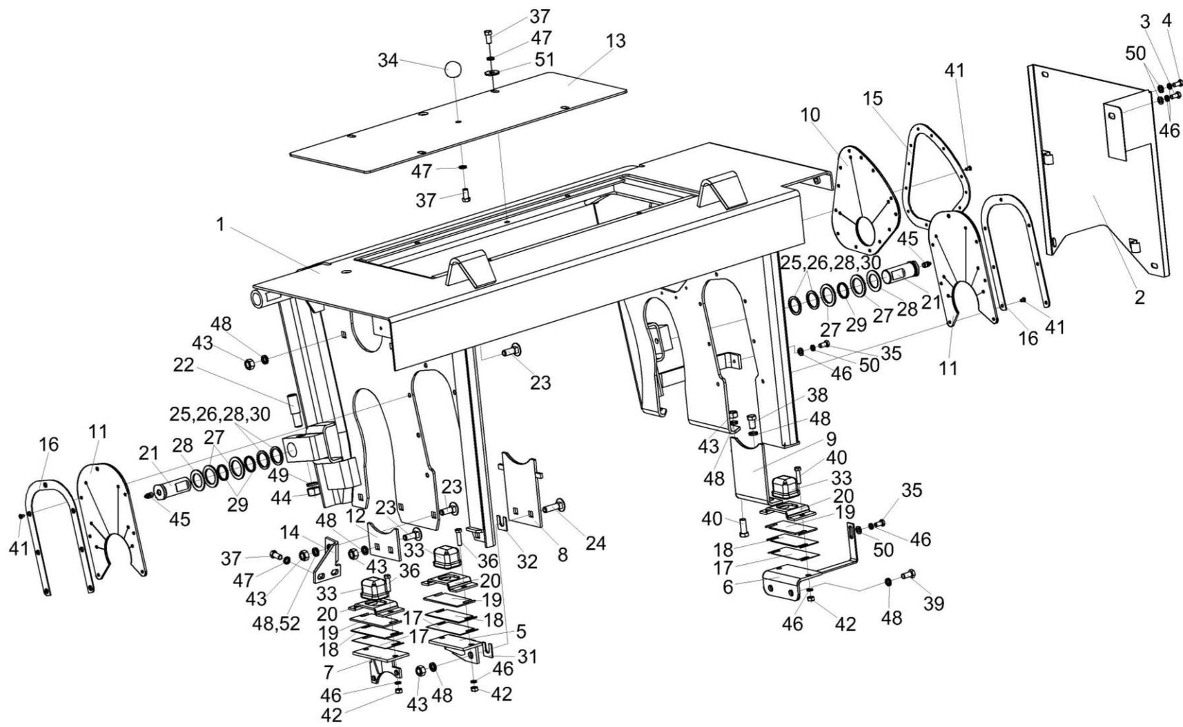
Рисунок 5 – Установка рамы верхней KBC-2-0111300B-01 аппарата питающего
