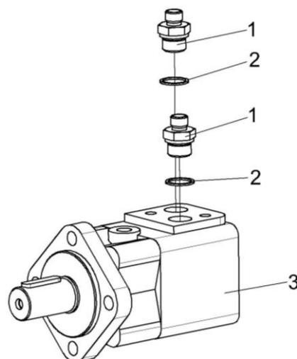
Рисунок 34 – Гидромотор заточного устройства КВС-1-0602650
