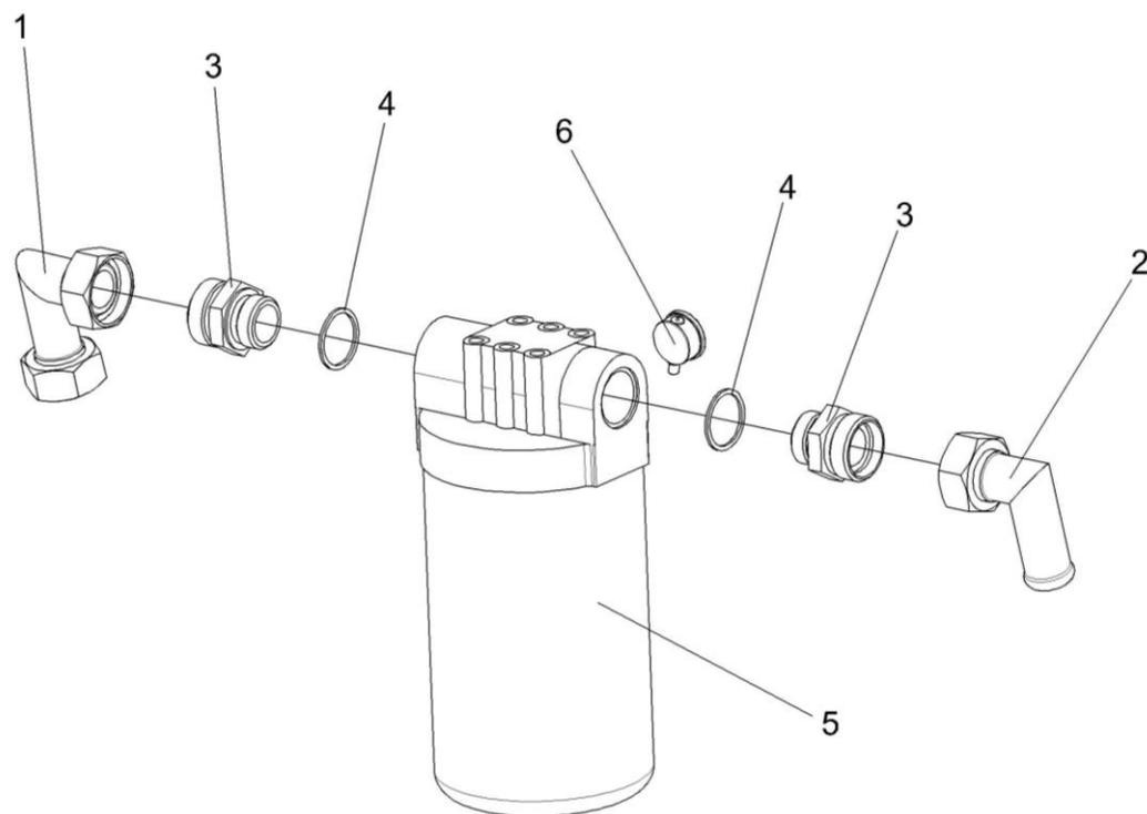
Рисунок 187 – Фильтр всасывающий КВС-2-0601090Б
