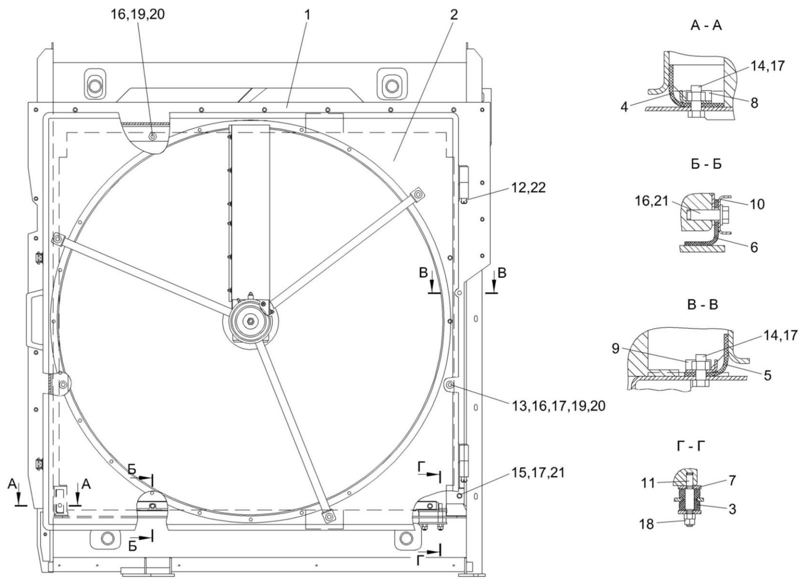
Рисунок 79 – Установка блока радиаторов КВС-2-0152000А (лист 2)
