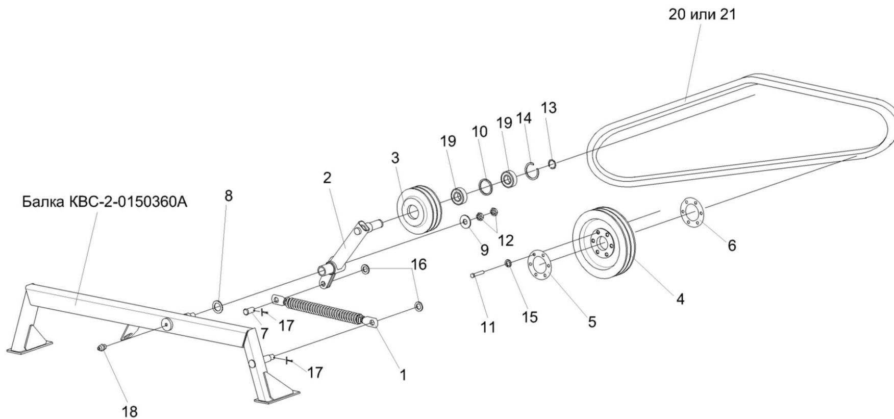
Рисунок 70 – Привод вентилятора КВС-2-0150090А
