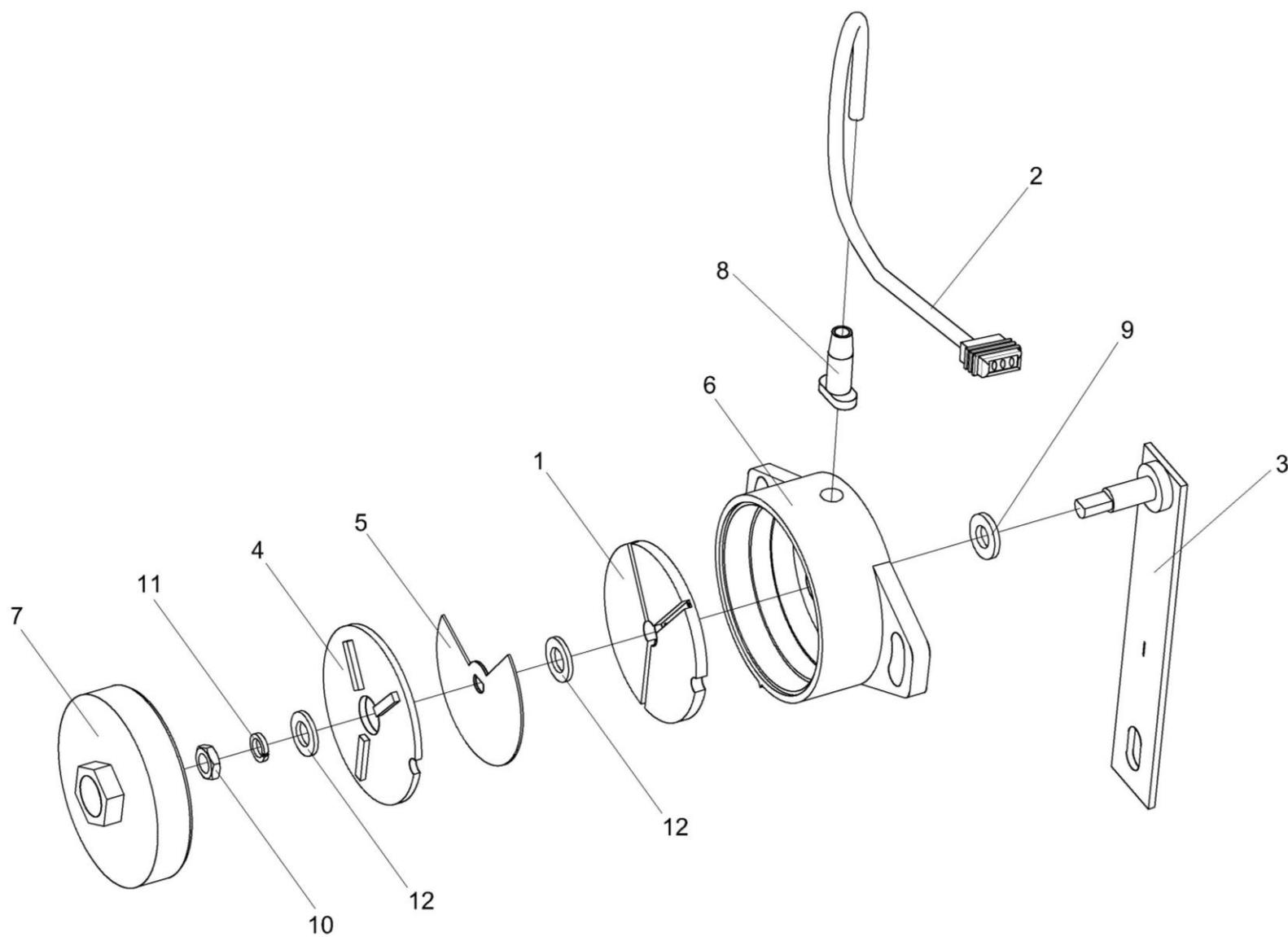
Рисунок 29 – Датчик положения КВС-1-0701500-01
