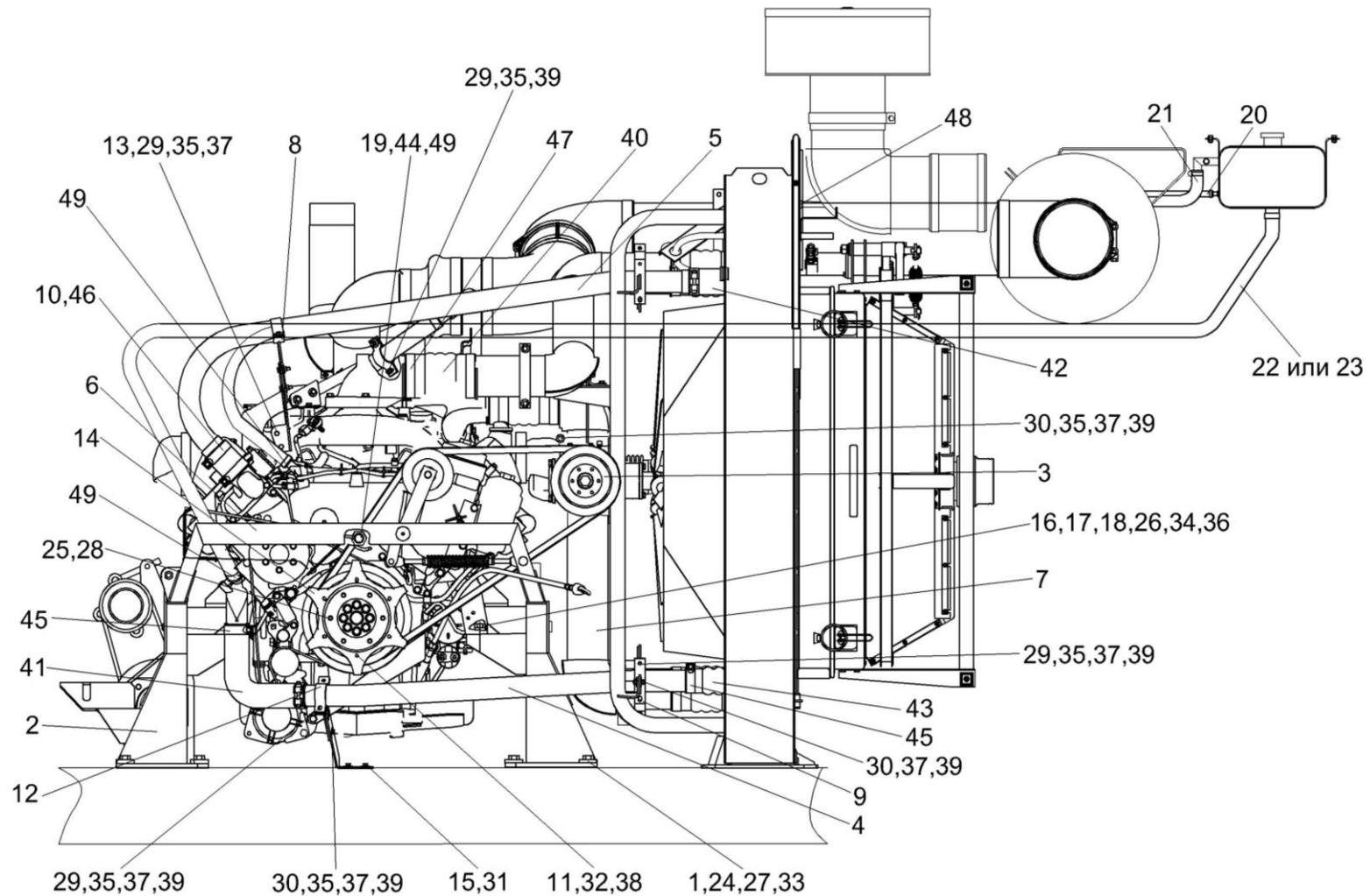
Рисунок 65 – Установка дизеля OM 502LA КВС-2-0150000В (лист 1)
