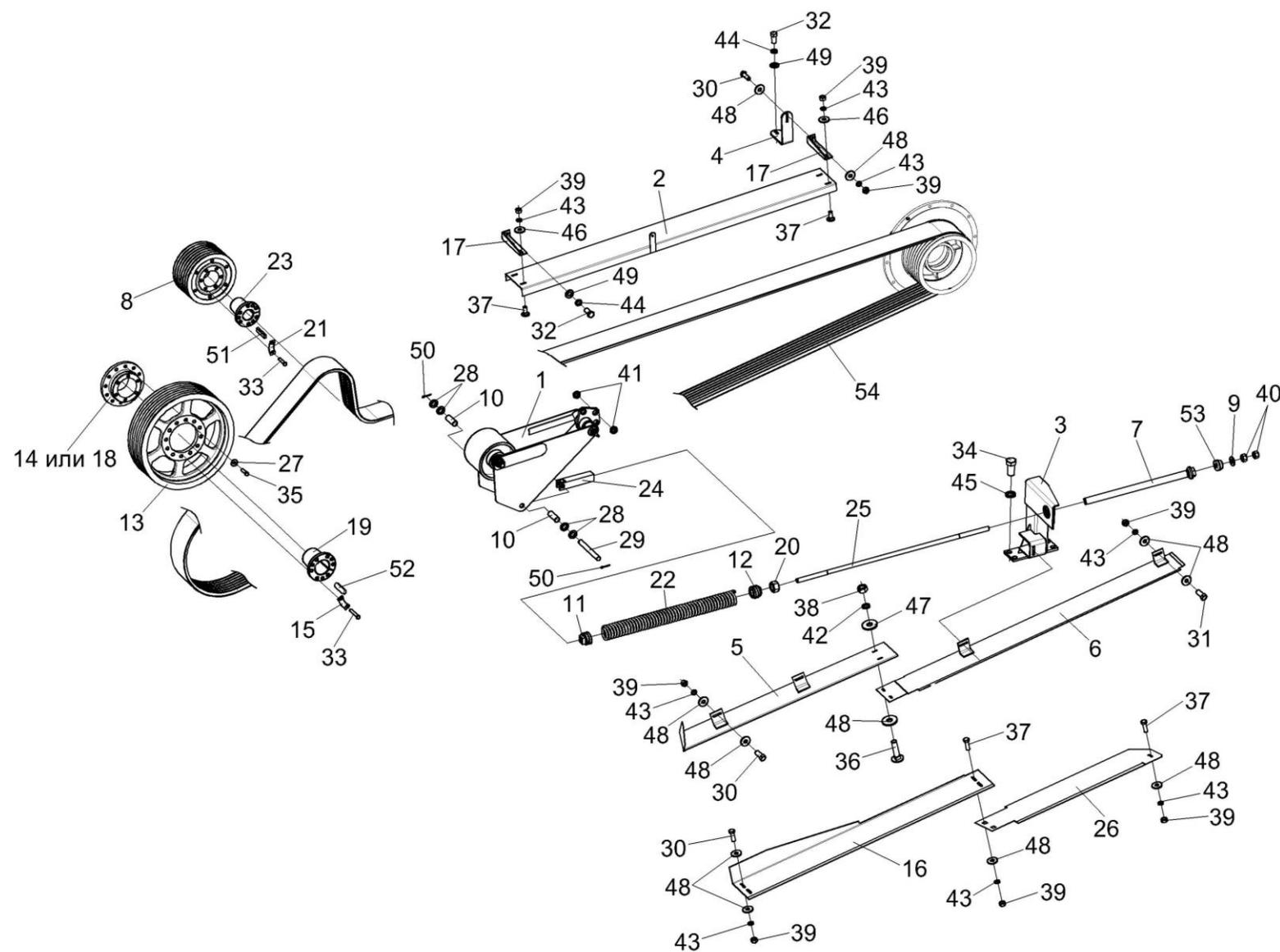
Рисунок 36 – Привод измельчающего барабана КВС-2-0130000-01
