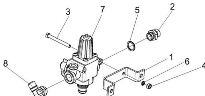
Рисунок 207 – Регулятор давления КВС-2-0800180
