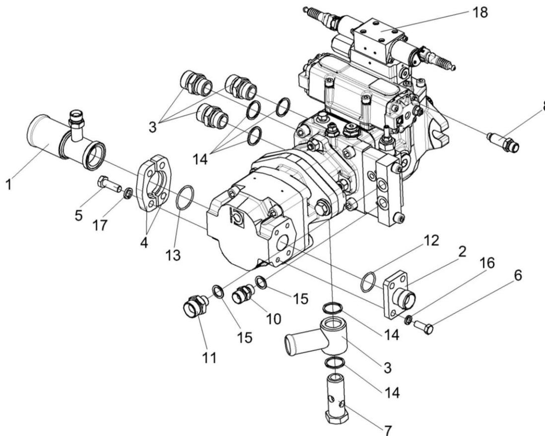
Рисунок 181 – Гидронасос двухсекционный КВС-5-0604330
