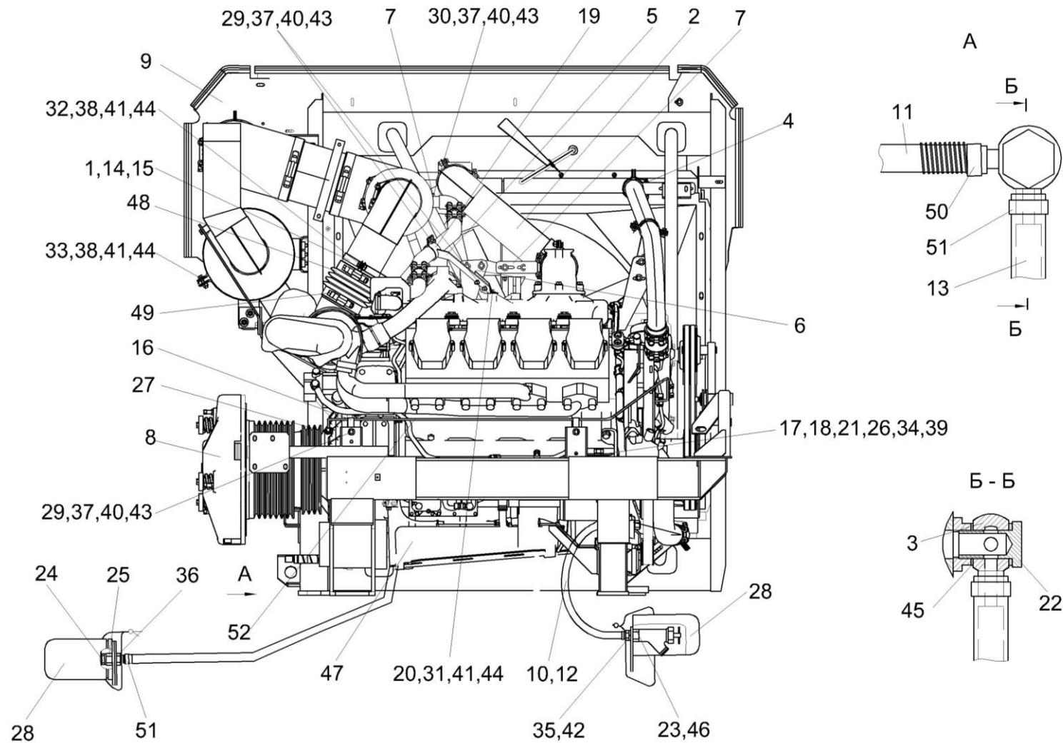
Рисунок 66 – Установка дизеля OM 502LA КВС-2-0150000В (лист 2)
