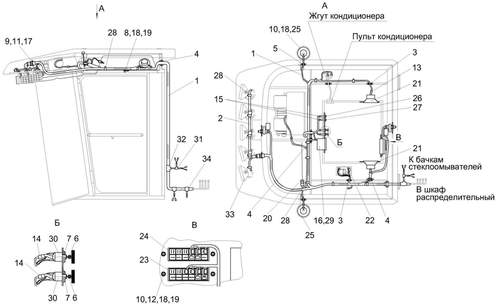
Рисунок 156 – Электрооборудование кабины KBC-2-0122000
