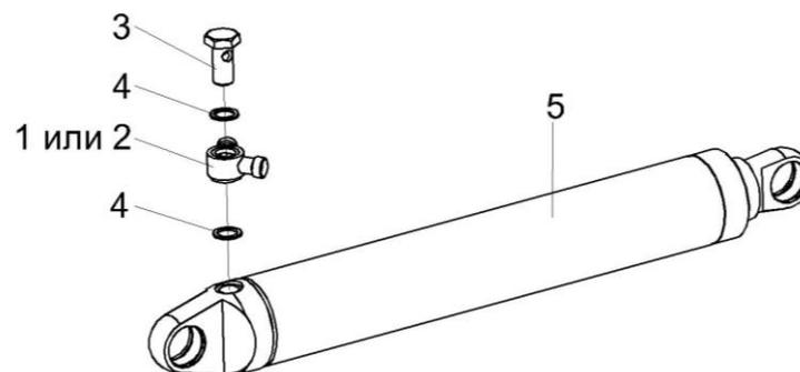
Рисунок 195 – Гидроцилиндр КВС-1-0602440 и КВС-1-0602440-01
