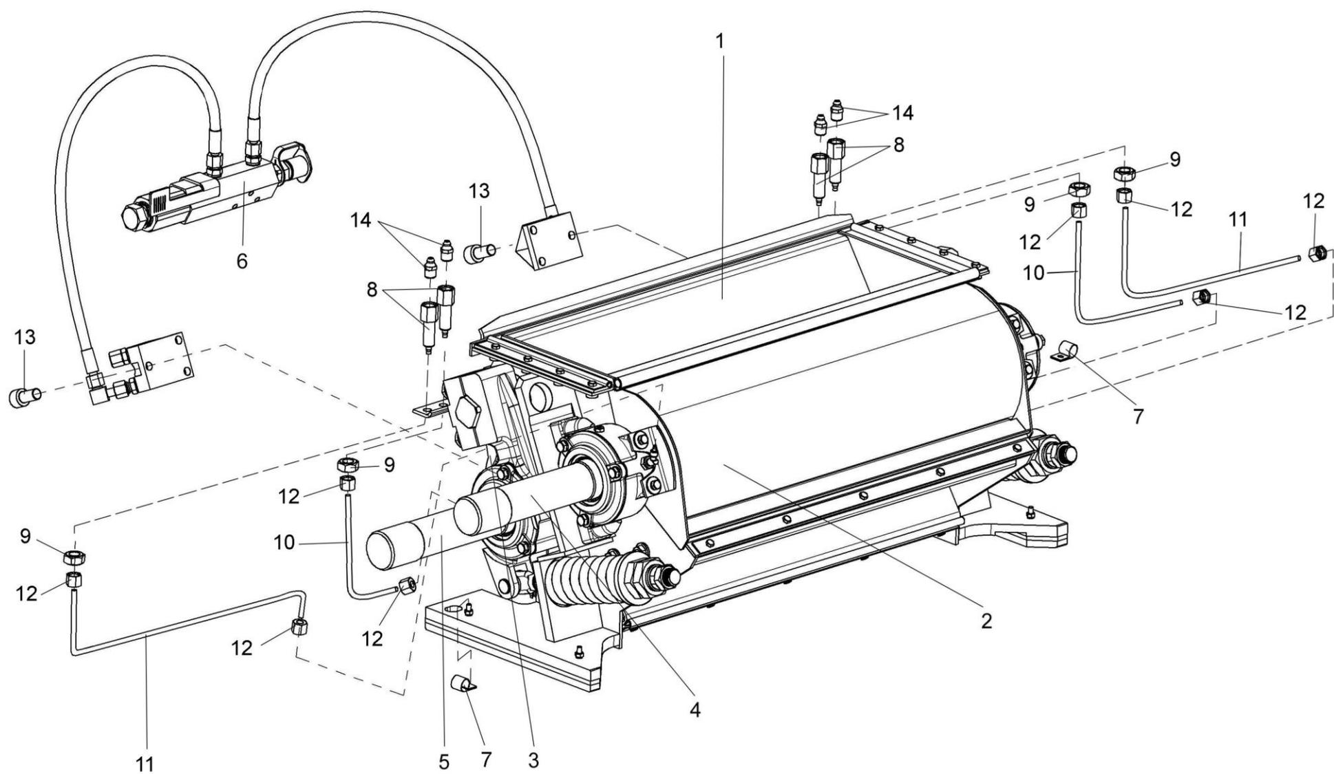
Рисунок 42 – Устройство доизмельчающее KBC-1-0148310
