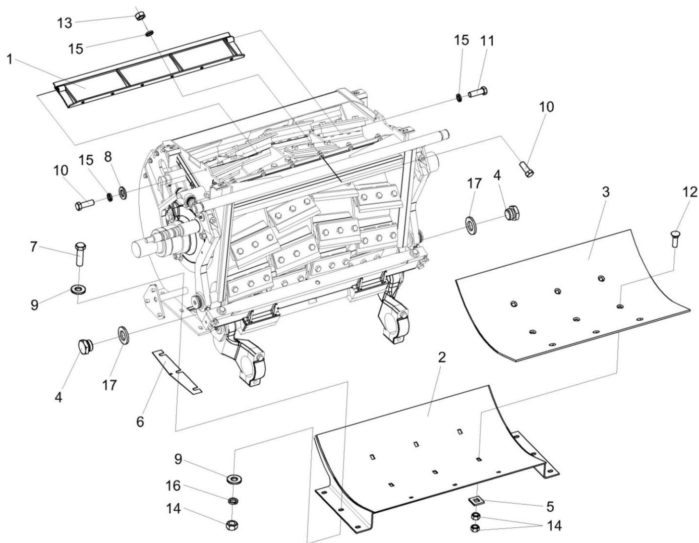
Рисунок 24 – Установка поддона KBC-2-0115050
