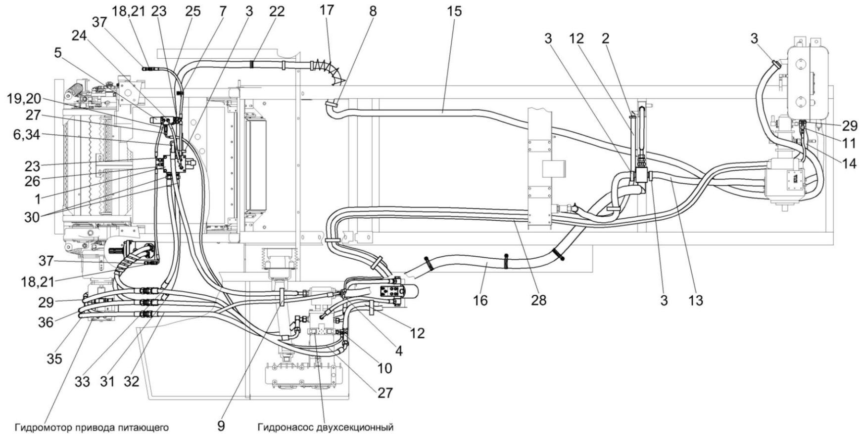
Рисунок 175 – Гидросистема привода питающего аппарата и адаптеров комбайна КВК-800-16 КВС-2-0624000 (вид сверху)
