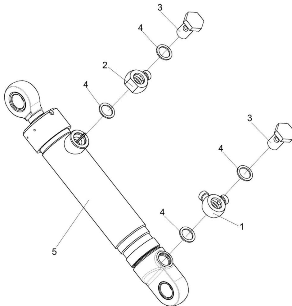
Рисунок 64 – Гидроцилиндр КВС-2-0602500
