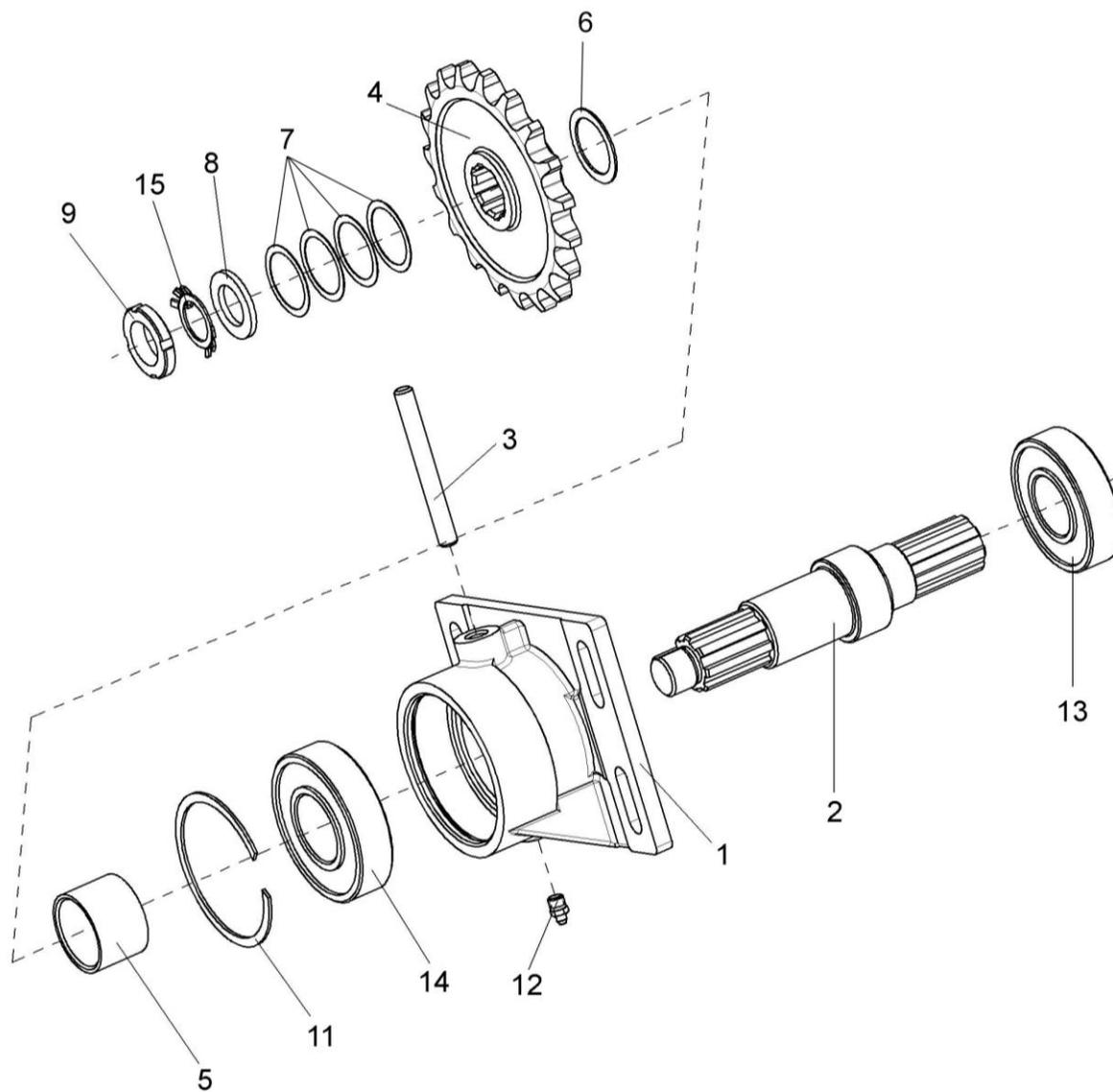
Рисунок 9 – Контрпривод КВС-1-0111170
