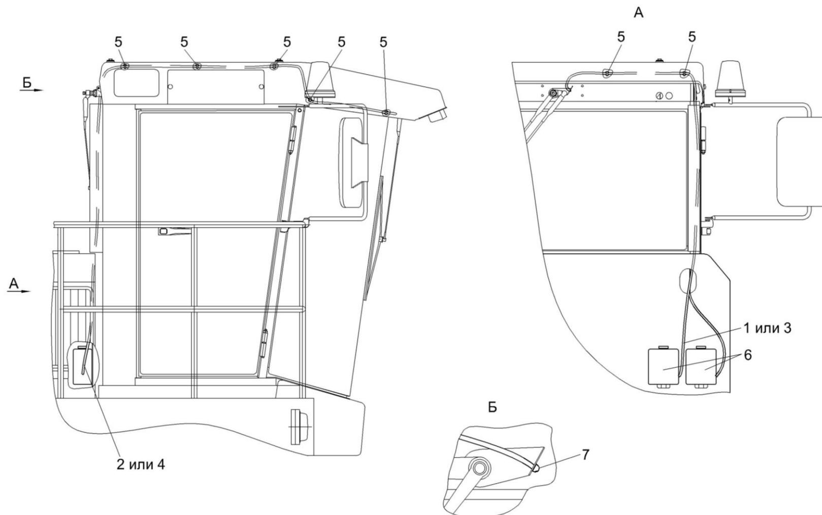
Рисунок 157 – Установка стеклоомывателей КВС-2-0122030
