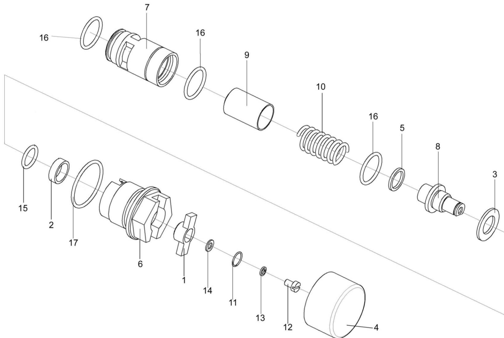
Рисунок 193 – Клапан-сигнализатор УЭС 0603660-01
