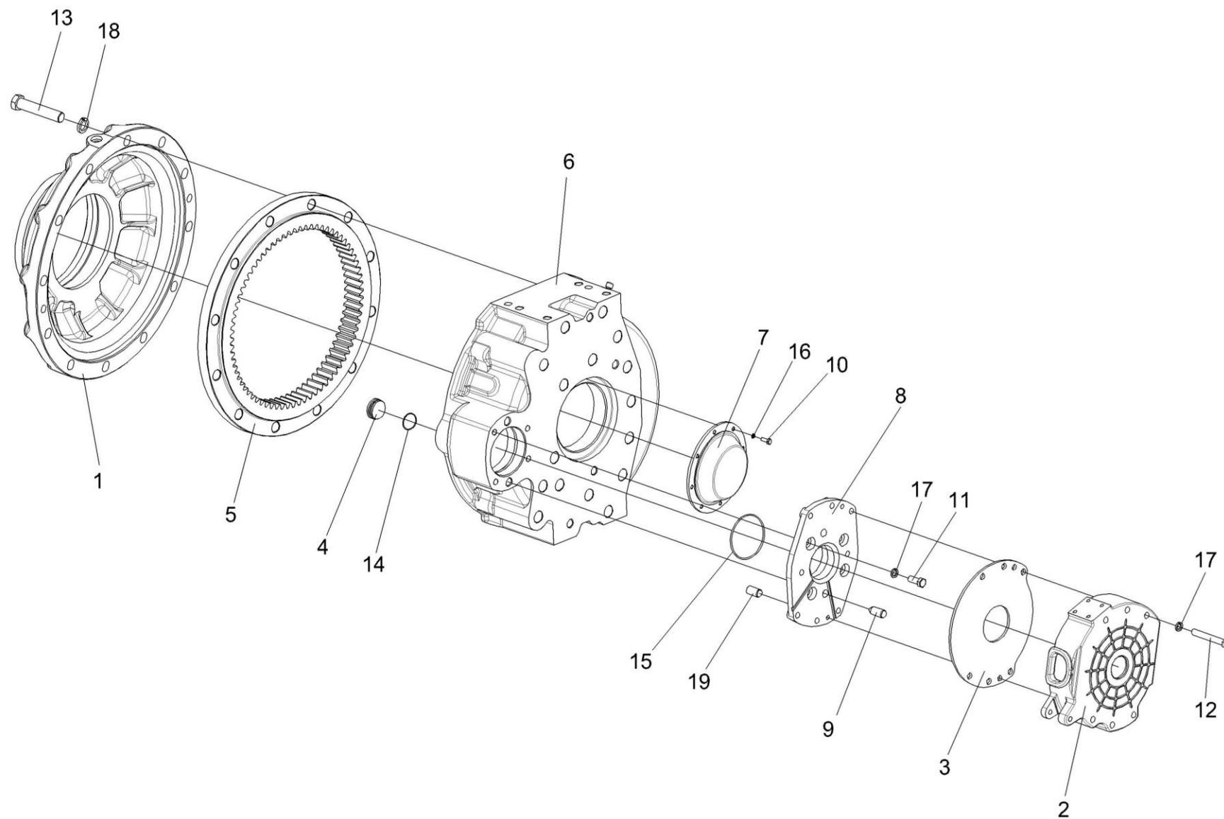
Рисунок 102 – Редуктор бортовой КЗК-10-0107200-02. Корпуса и крышки
