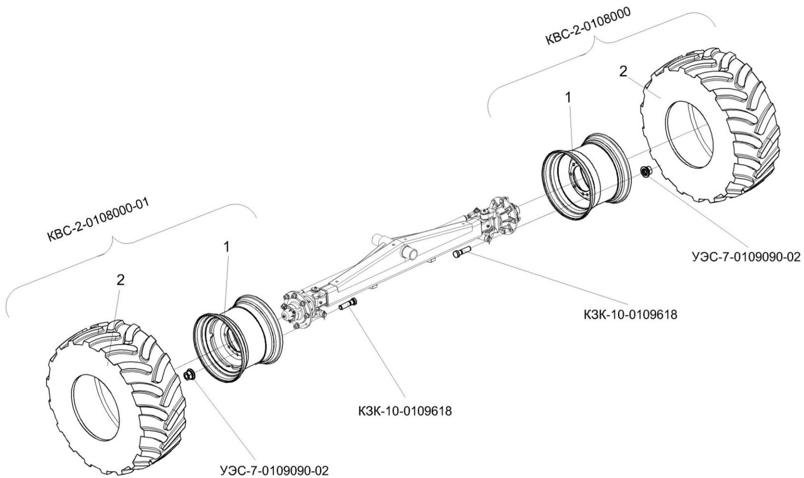
Рисунок 120 – Установка колес КВС-2-0108000 и КВС-2-0108000-01
