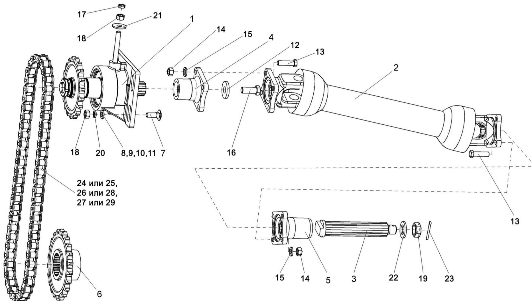
Рисунок 6 – Установка карданного вала КВС-1-0119000-01
