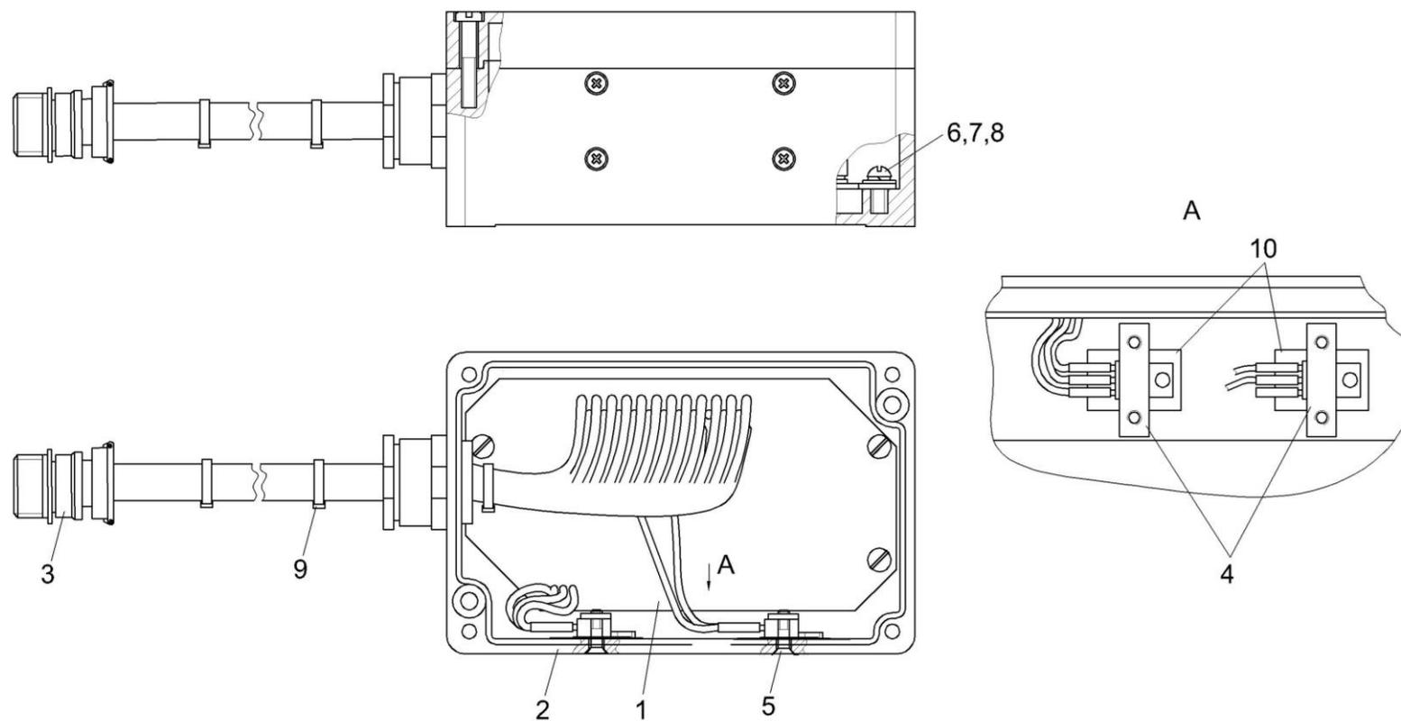
Рисунок 130 – Блок регулировки питающим аппаратом KBC-2-0701800A
