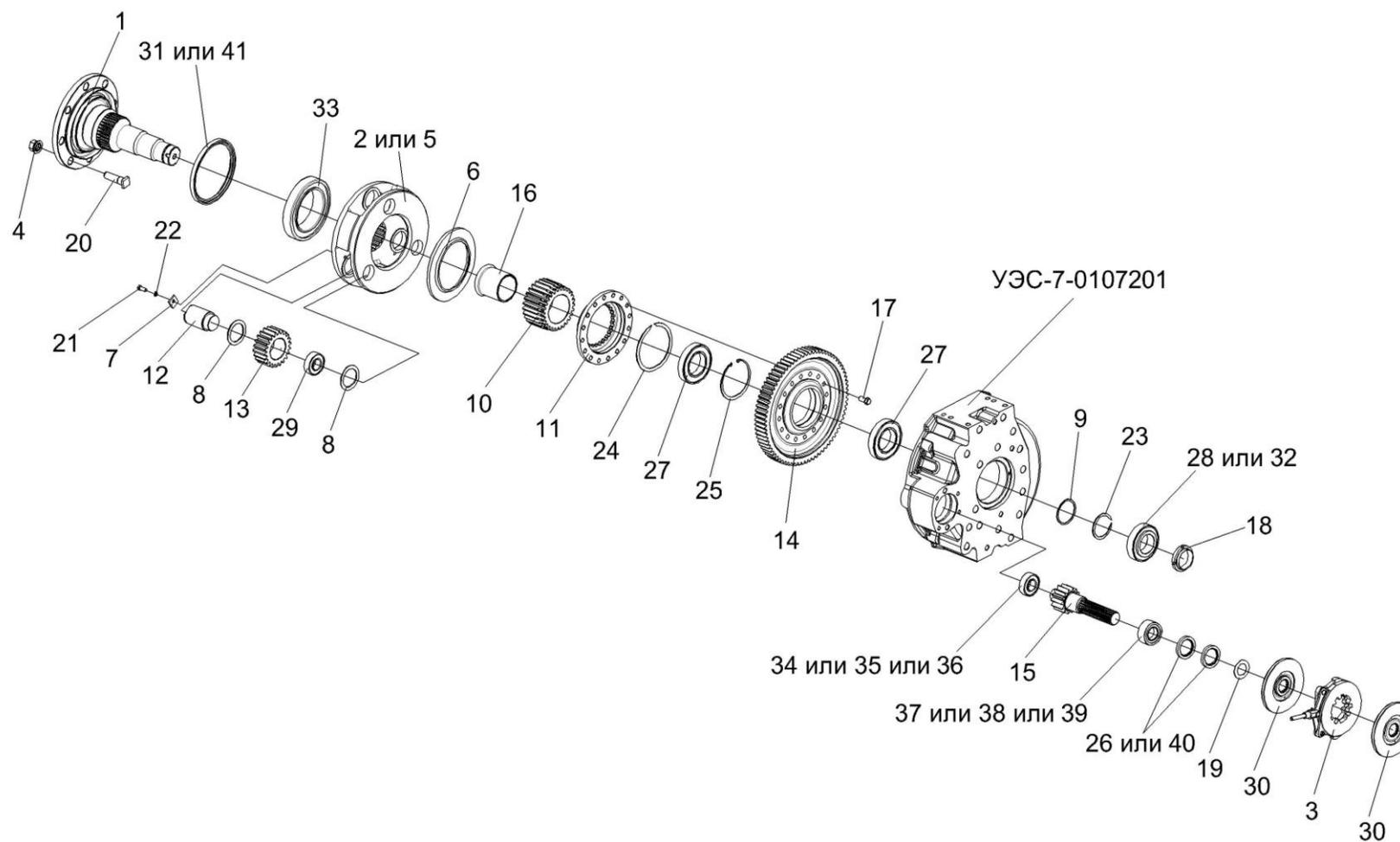
Рисунок 103 – Редуктор бортовой КЗК-10-0107200-02. Валы и шестерни
