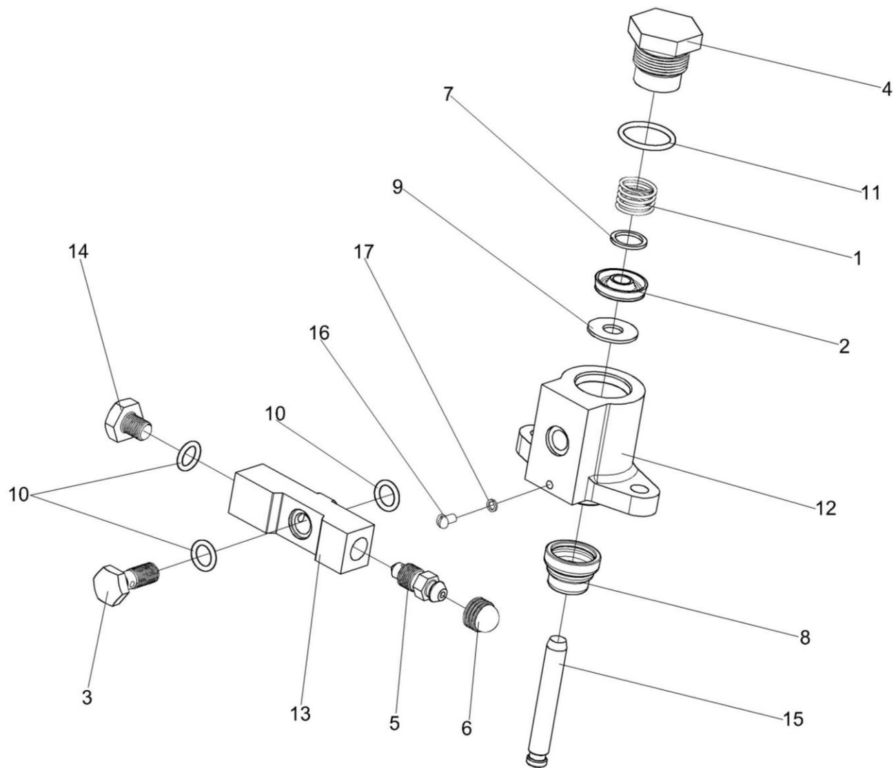
Рисунок 113 – Гидроцилиндр блокировки диапазонов 3518020-46330
