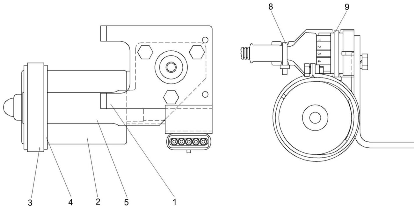
Рисунок 214 – Электропривод на опоре KBC-2-0701430-01
