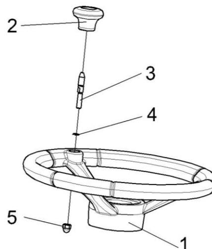
Рисунок 137 – Колесо рулевое УЭС 0302560
