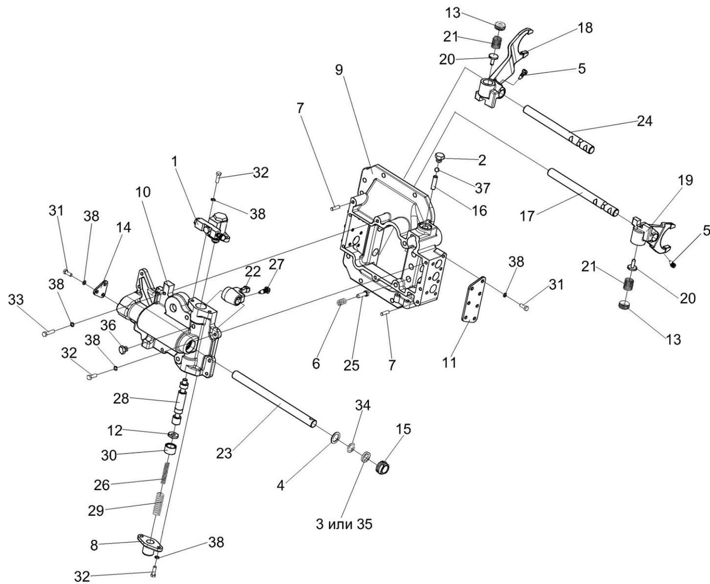
Рисунок 112 – Механизм переключения диапазонов 3518020-46160
