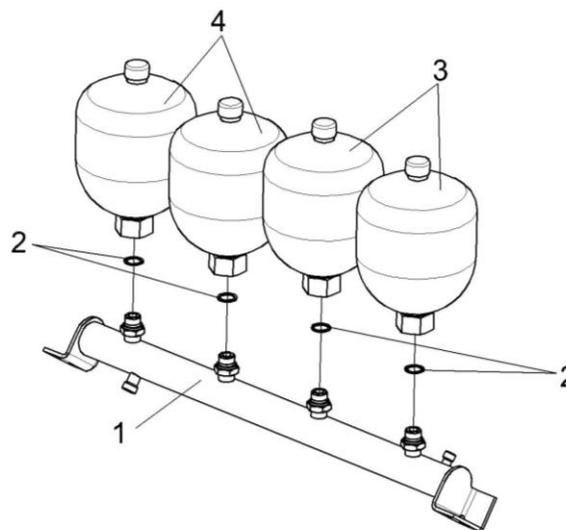
Рисунок 196 – Блок пневмогидроаккумуляторов KBC-1-0602540
