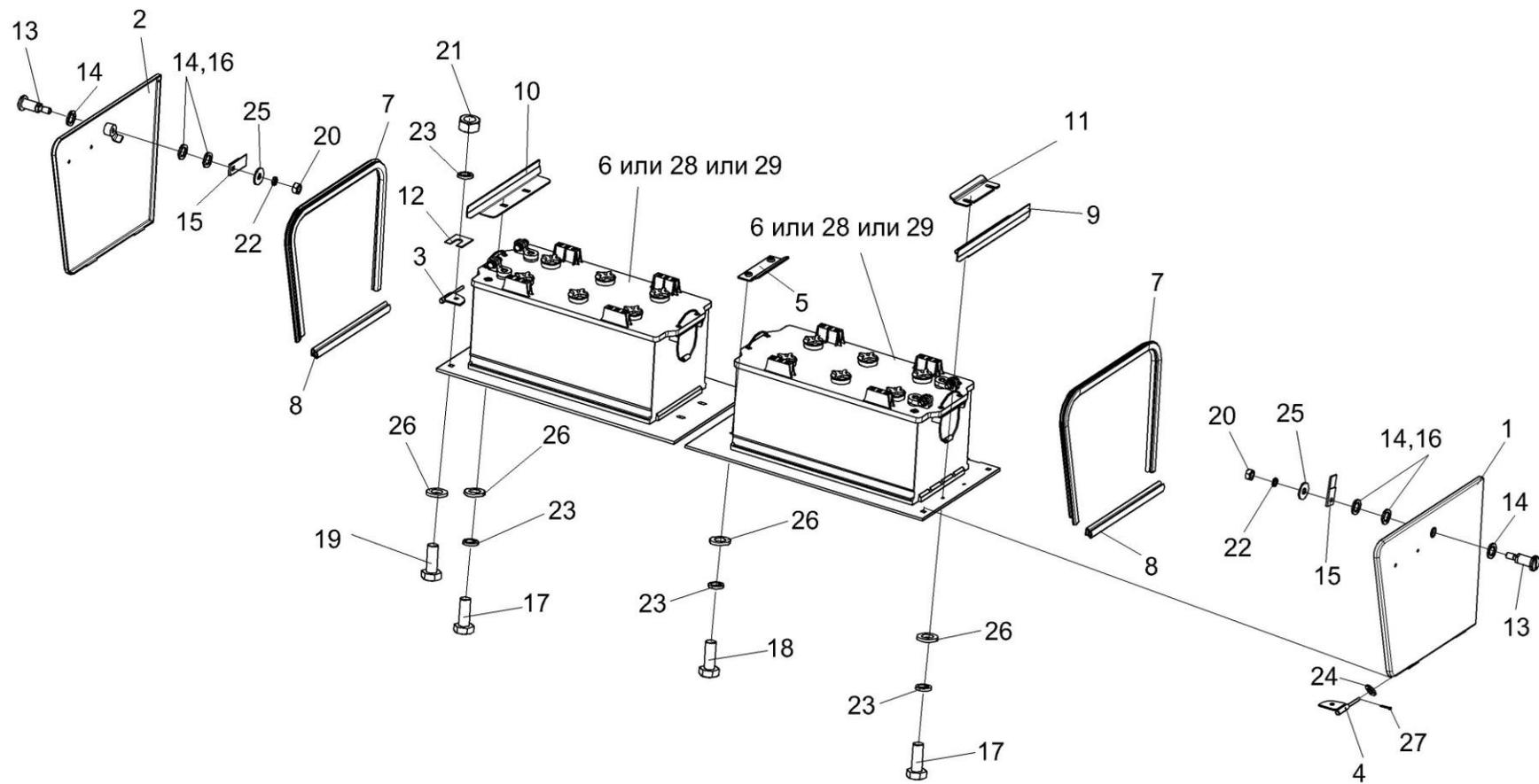
Рисунок 93 – Установка аккумуляторов КВС-2-0101020
