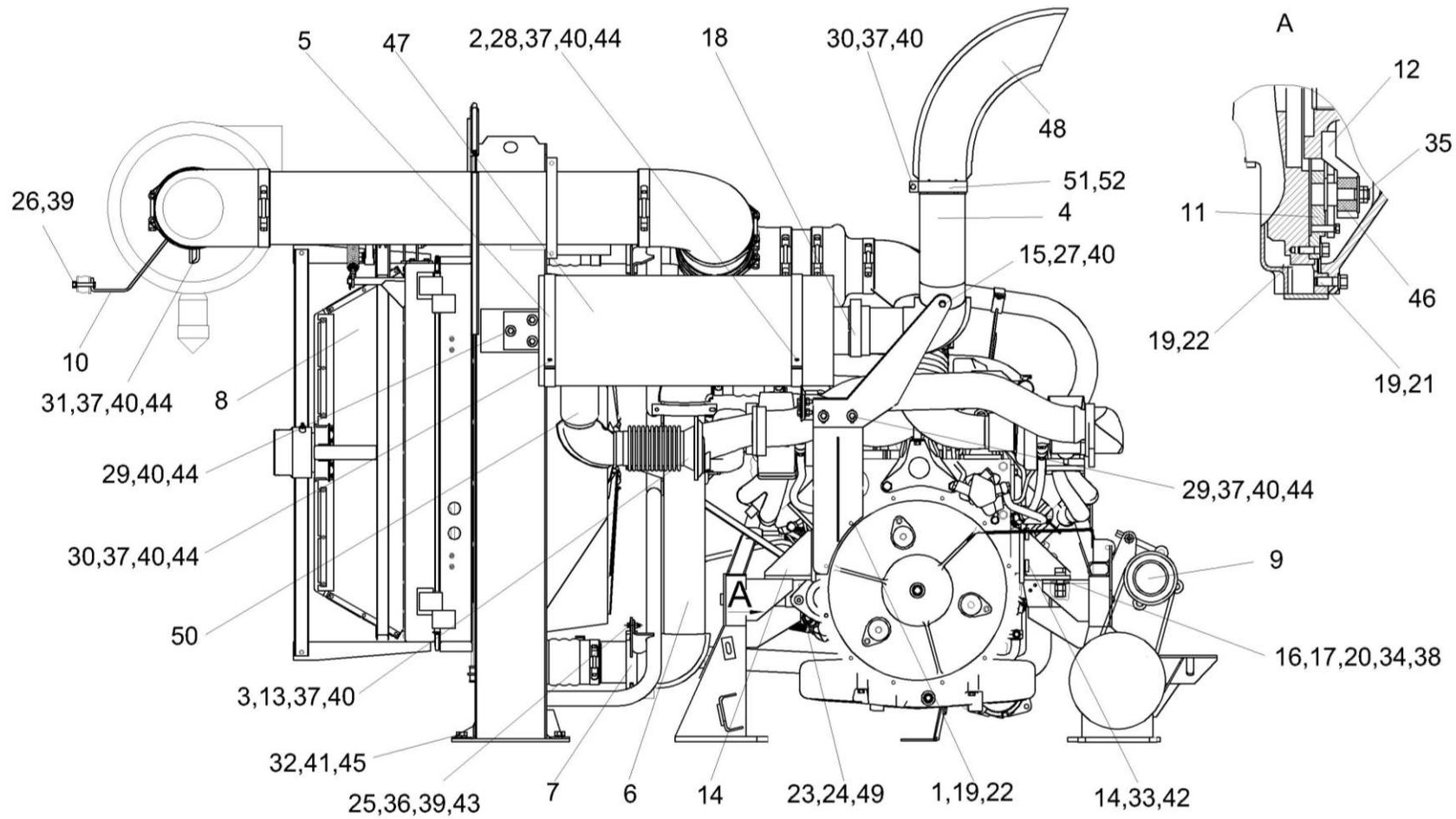
Рисунок 67 – Установка дизеля OM 502LA KBC-2-0150000B (лист 3)
