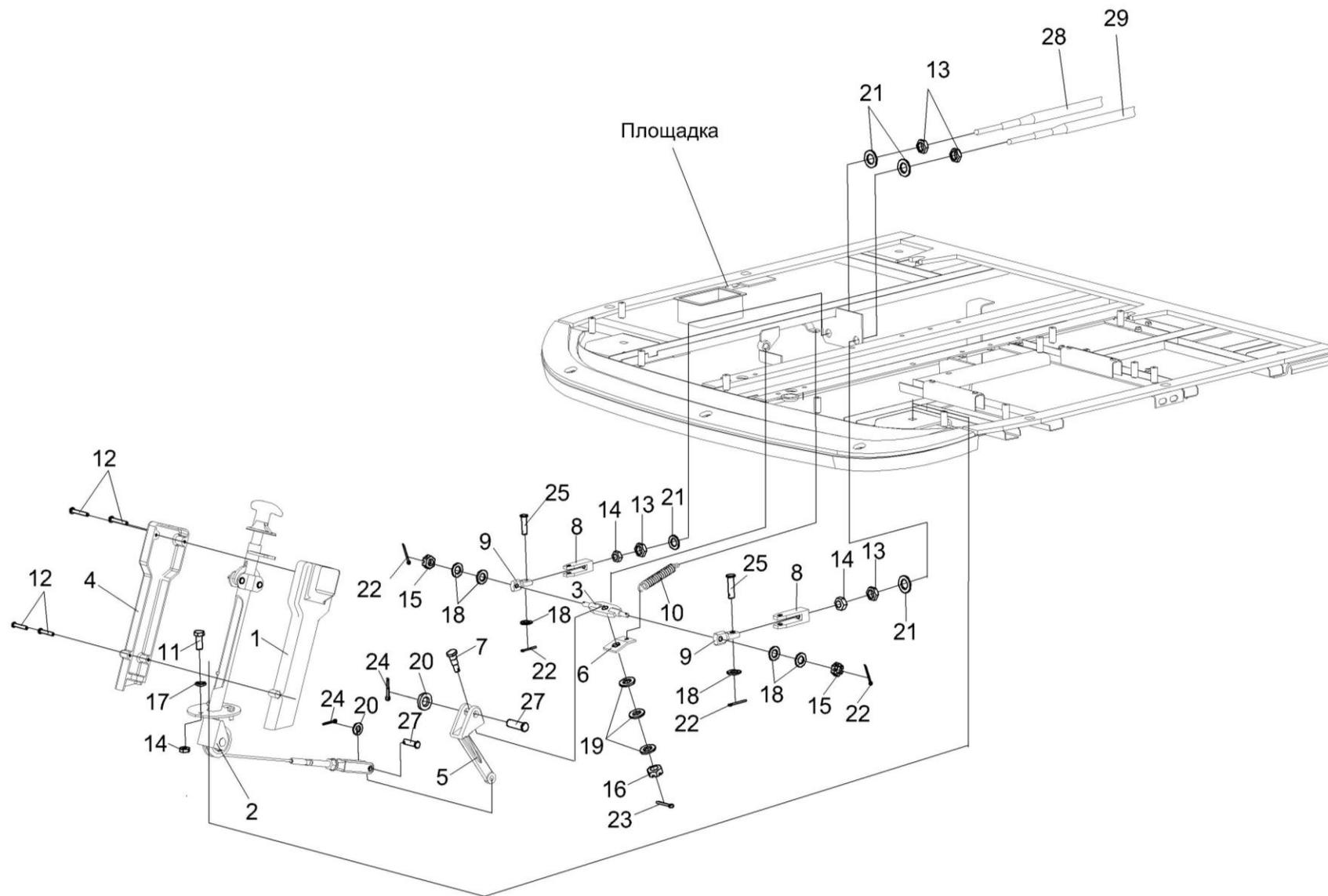
Рисунок 140 – Установка колонки привода УЭС 0300710
