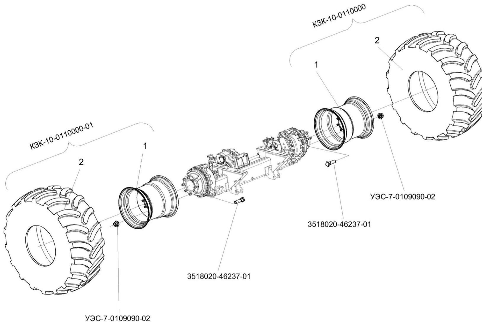
Рисунок 121 – Установка колес КЗК-10-0110000 и КЗК-10-0110000-01
