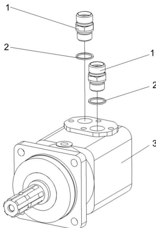
Рисунок 178 – Гидромотор привода адаптеров КГС 0115380
