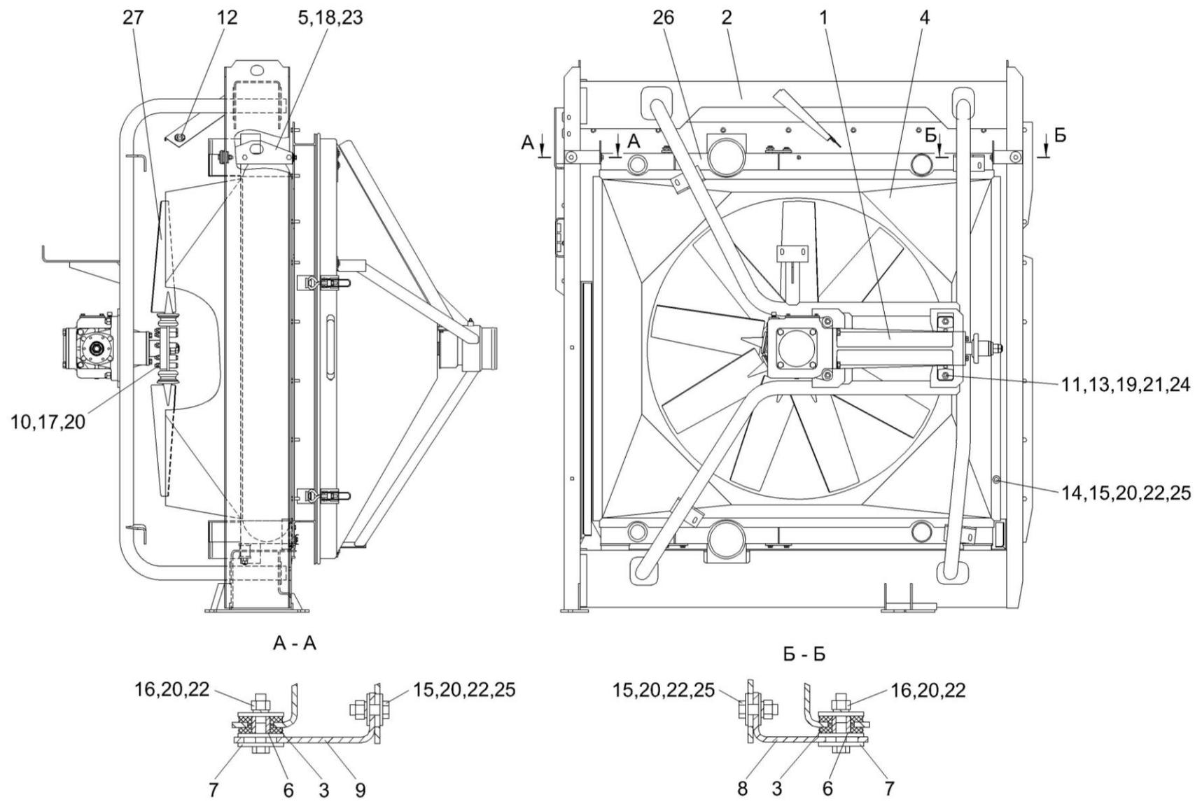
Рисунок 78 – Установка блока радиаторов КВС-2-0152000А (лист 1)
