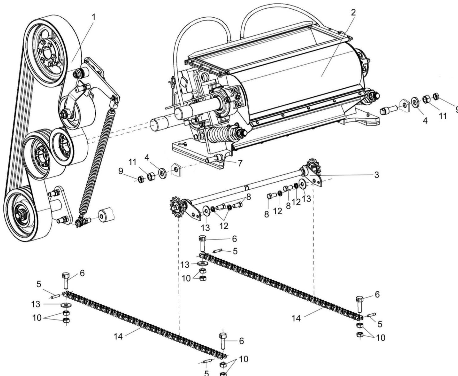
Рисунок 38 – Устройство доизмельчающее KBC-1-0148000
