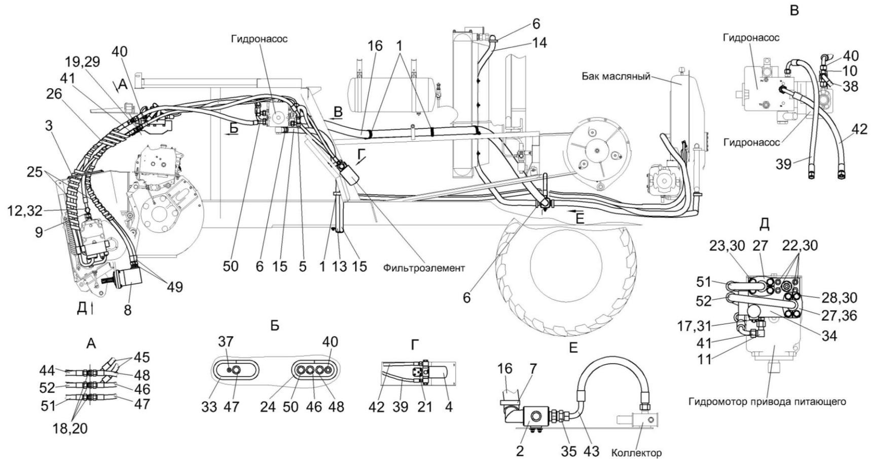
Рисунок 174 – Гидросистема привода питающего аппарата и адаптеров комбайна КВК-800-16 КВС-2-0624000 (вид сбоку)
