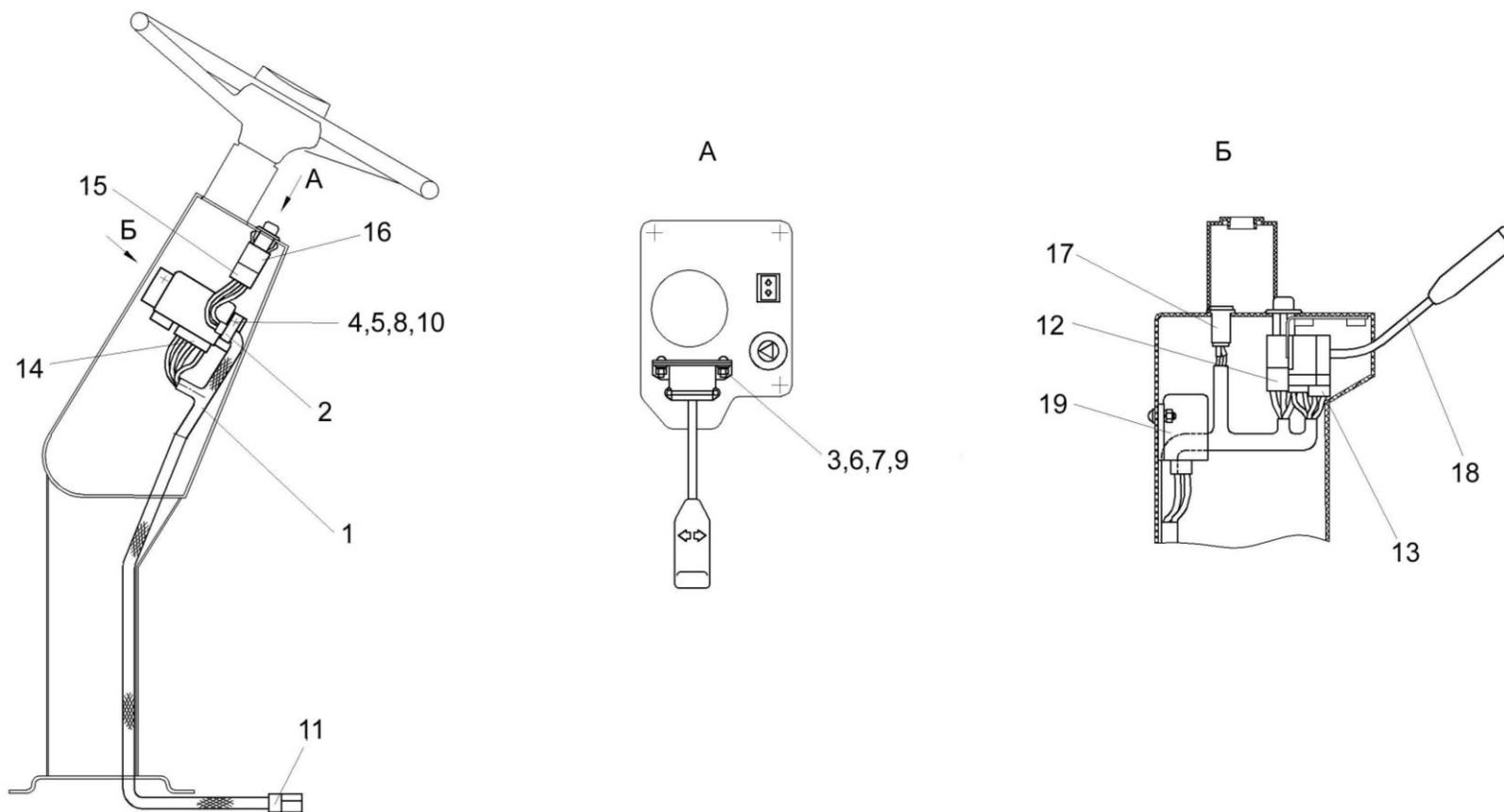
Рисунок 139 – Электрооборудование рулевой колонки KBC-1-0129230 или KBC-1-0129230-03
