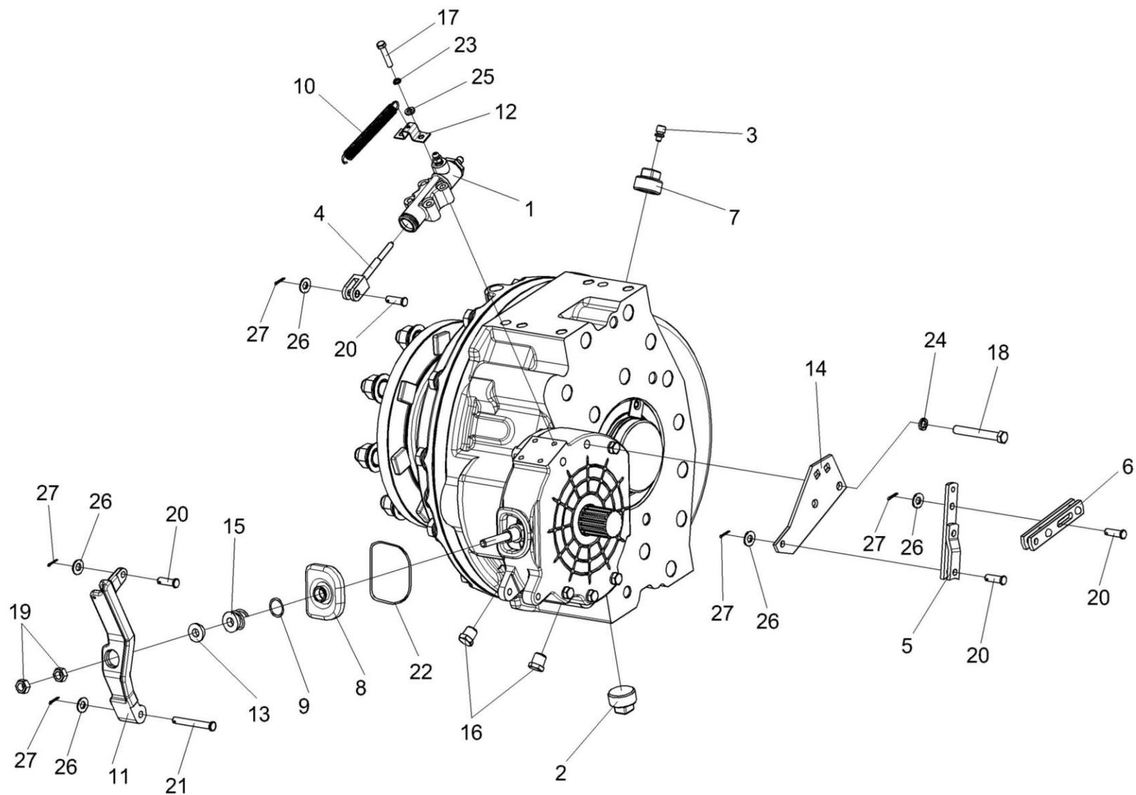
Рисунок 101 – Редуктор бортовой К3К-10-0107200-02
