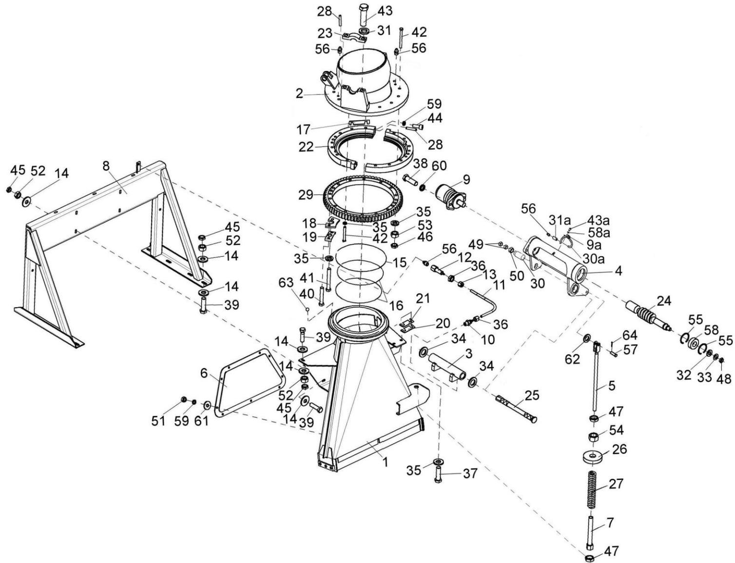
Рисунок 60 – Основание силопровода и механизм поворота КВС-1-0143000
