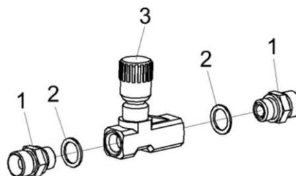
Рисунок 194 – Дроссель с обратным клапаном регулируемый КВС-1-0602170
