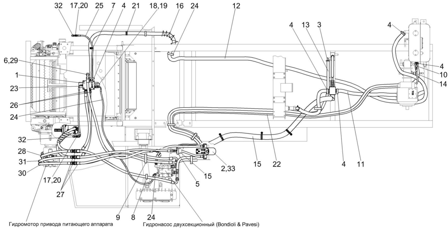
Рисунок 173 – Гидросистема привода питающего аппарата и адаптеров комбайна КВК-800-16 КВС-2-0604000Б (вид сверху)
