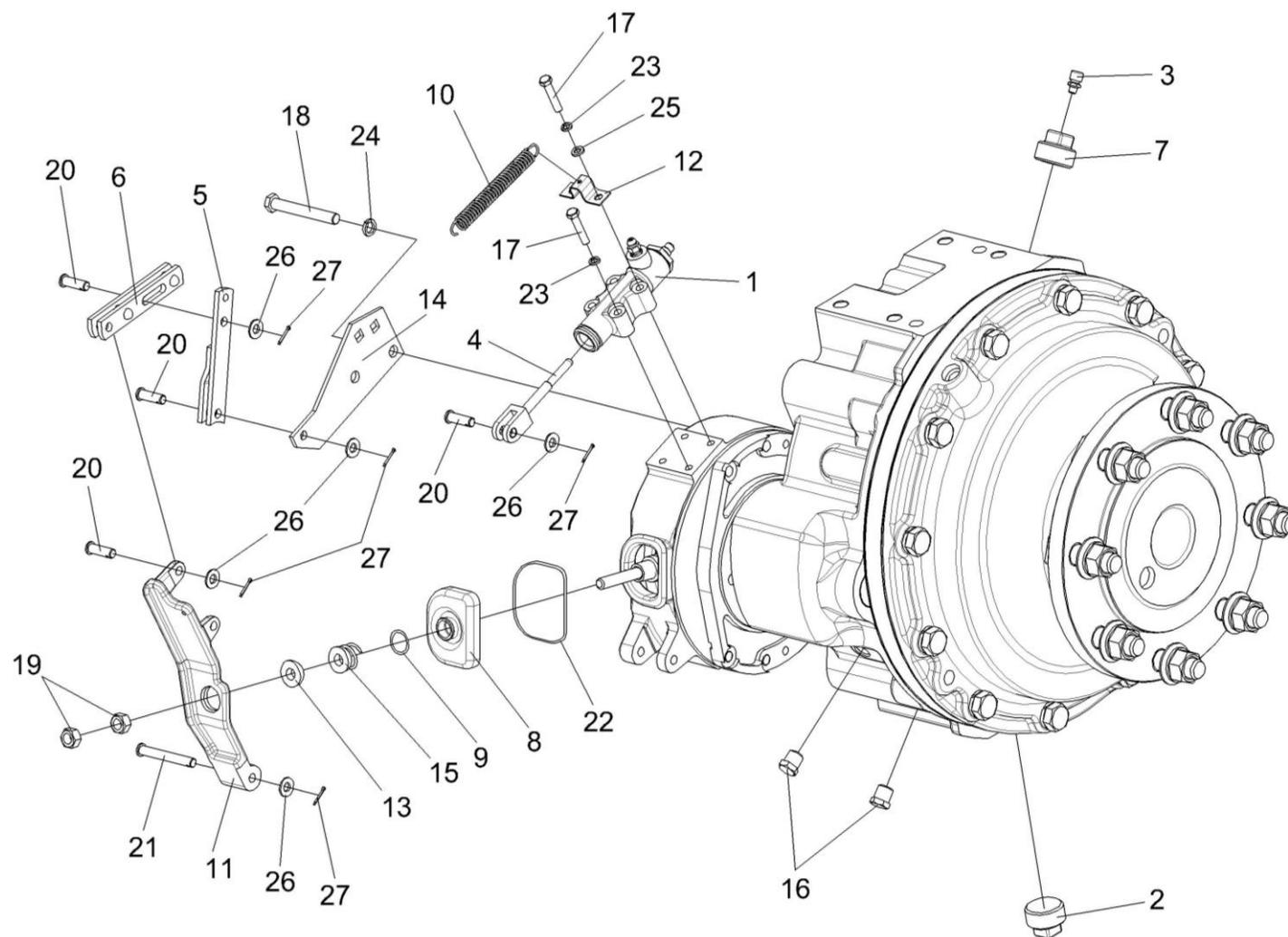
Рисунок 104 – Редуктор бортовой КЗК-10-0107200-03
