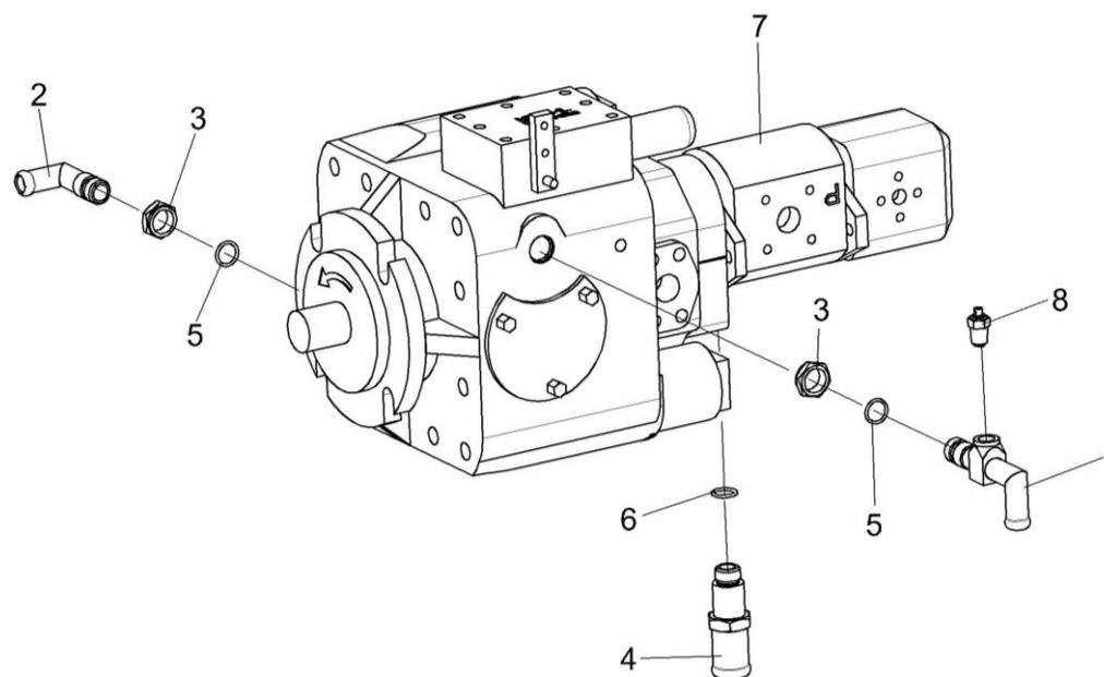
Рисунок 89 – Насос трехсекционный КВС-2-0601200
