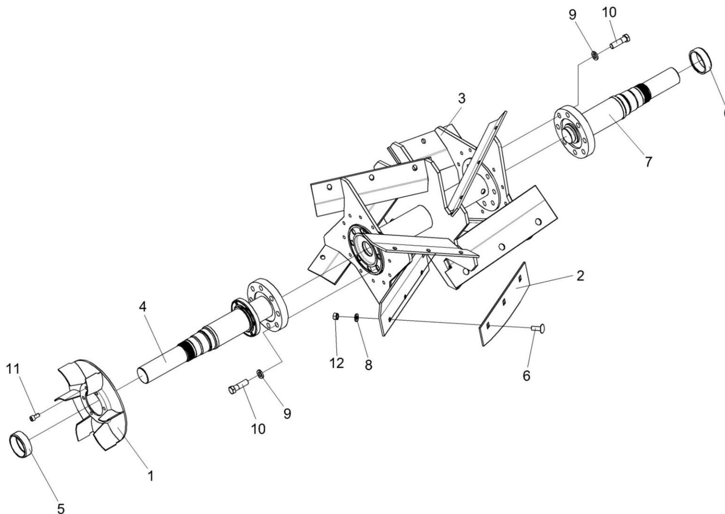
Рисунок 58 – Вал ускорителя выброса КВС-1-0142910
