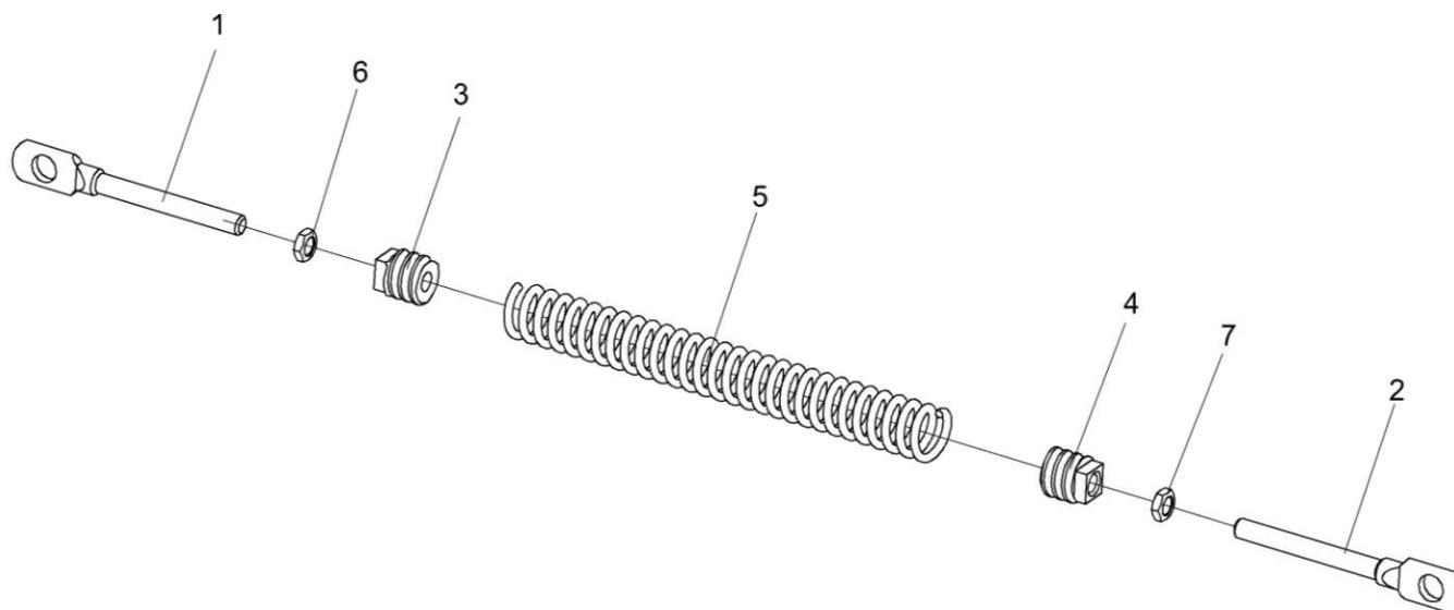
Рисунок 71 – Механизм натяжения КВС-2-0150120
