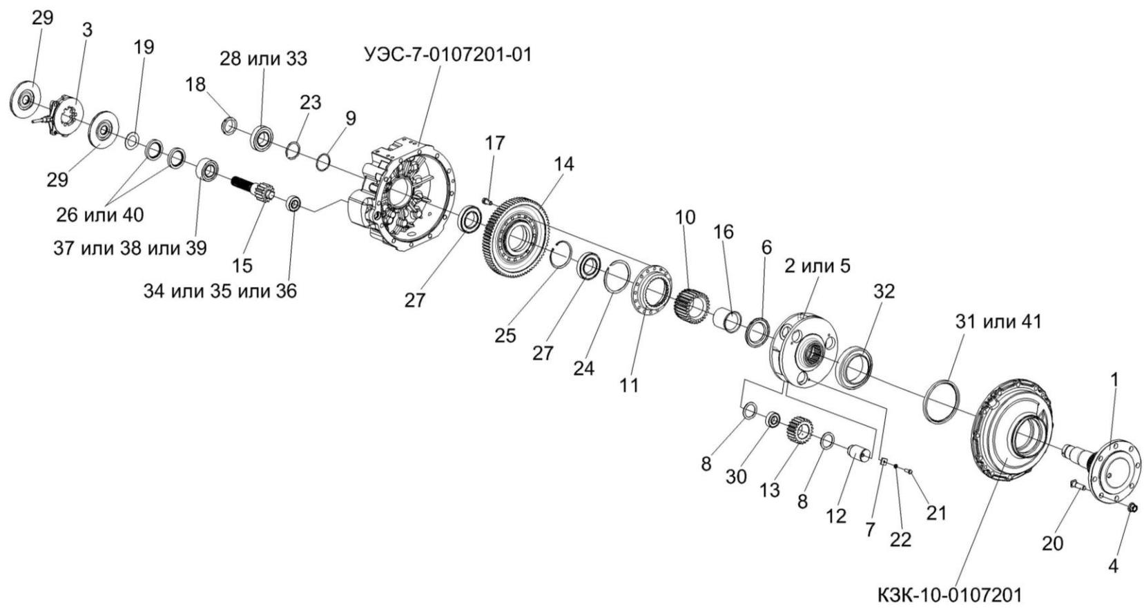
Рисунок 106 – Редуктор бортовой КЗК-10-0107200-03. Валы и шестерни
