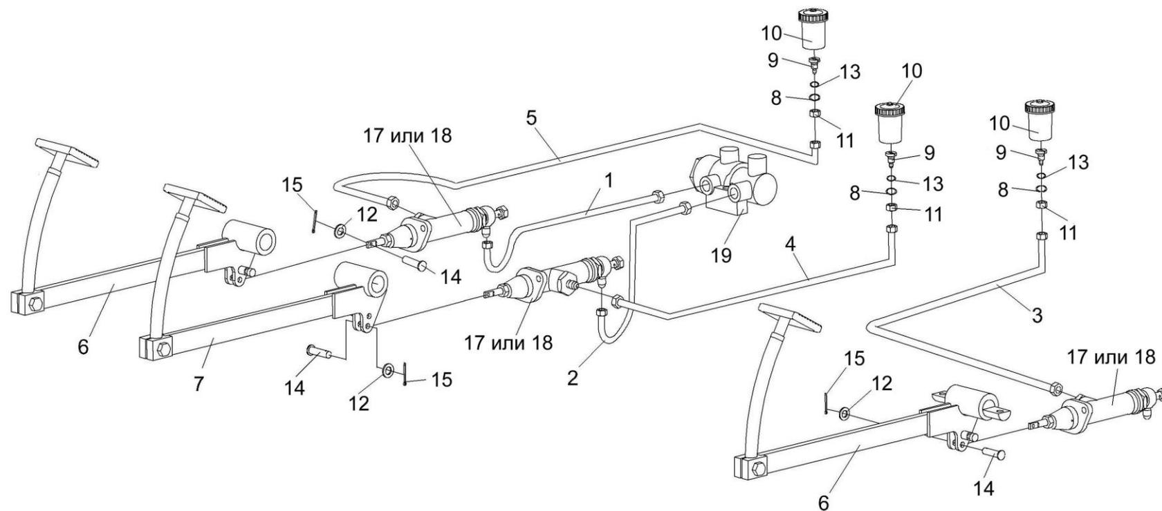
Рисунок 124 – Рычаги и трубопроводы площадки управления
