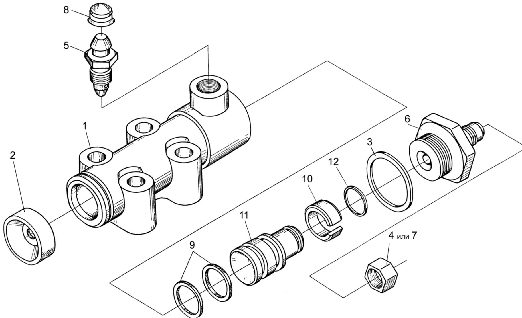
Рисунок 108 – Гидроцилиндр тормоза МК-23М.03.220А
