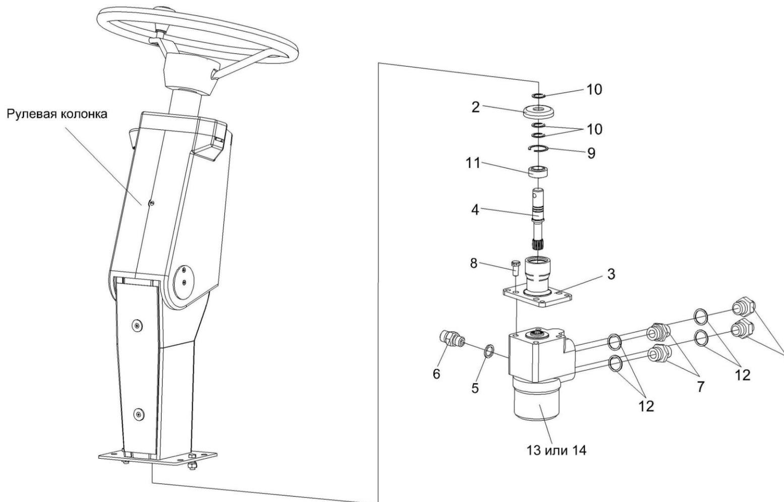
Рисунок 132 – Установка насоса-дозатора КВС-1-0602990 или КВС-1-0602990-01
