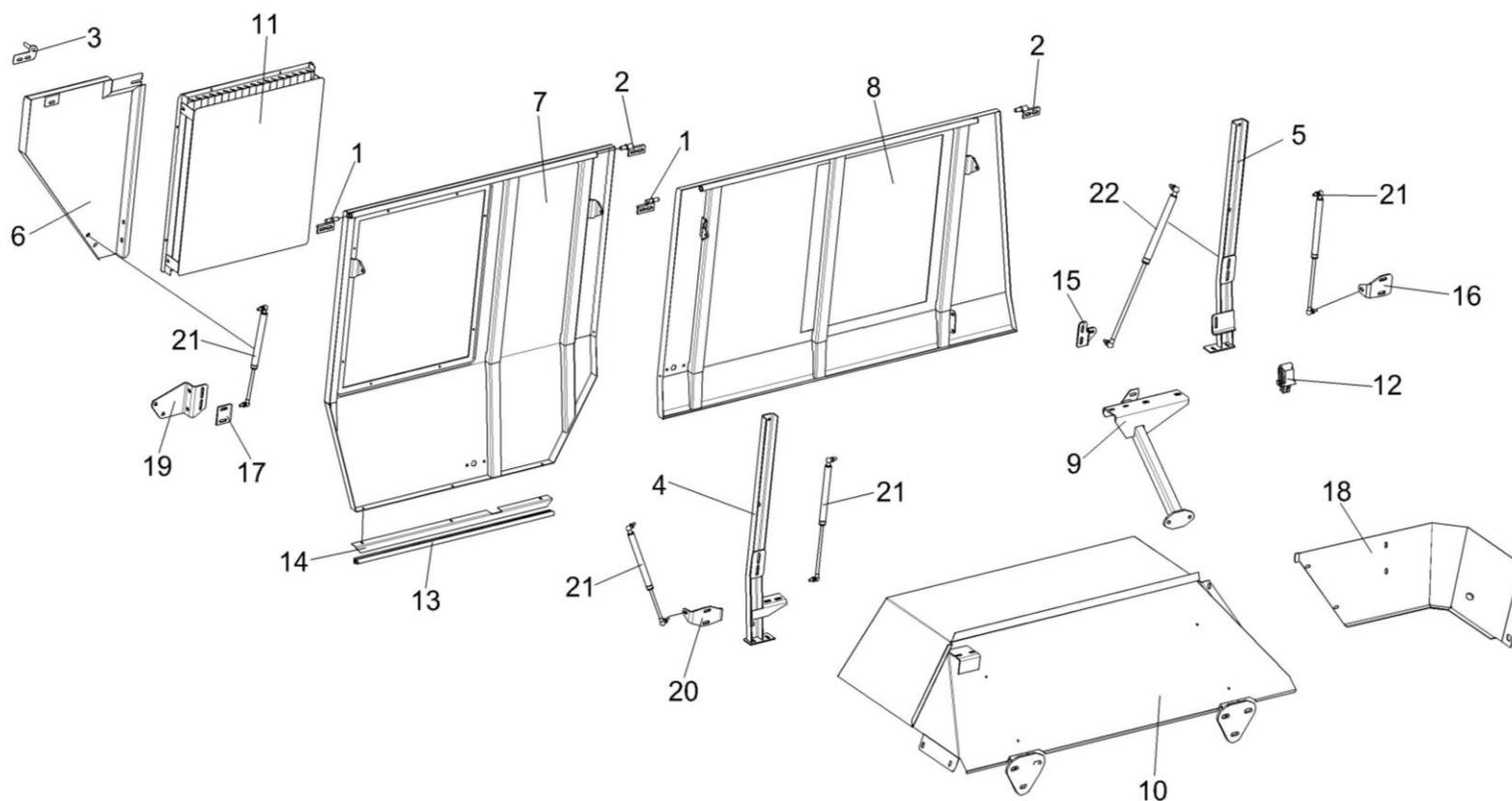
Рисунок 161 – Установка капотов КВС-2-0160000-02 (лист 2)
