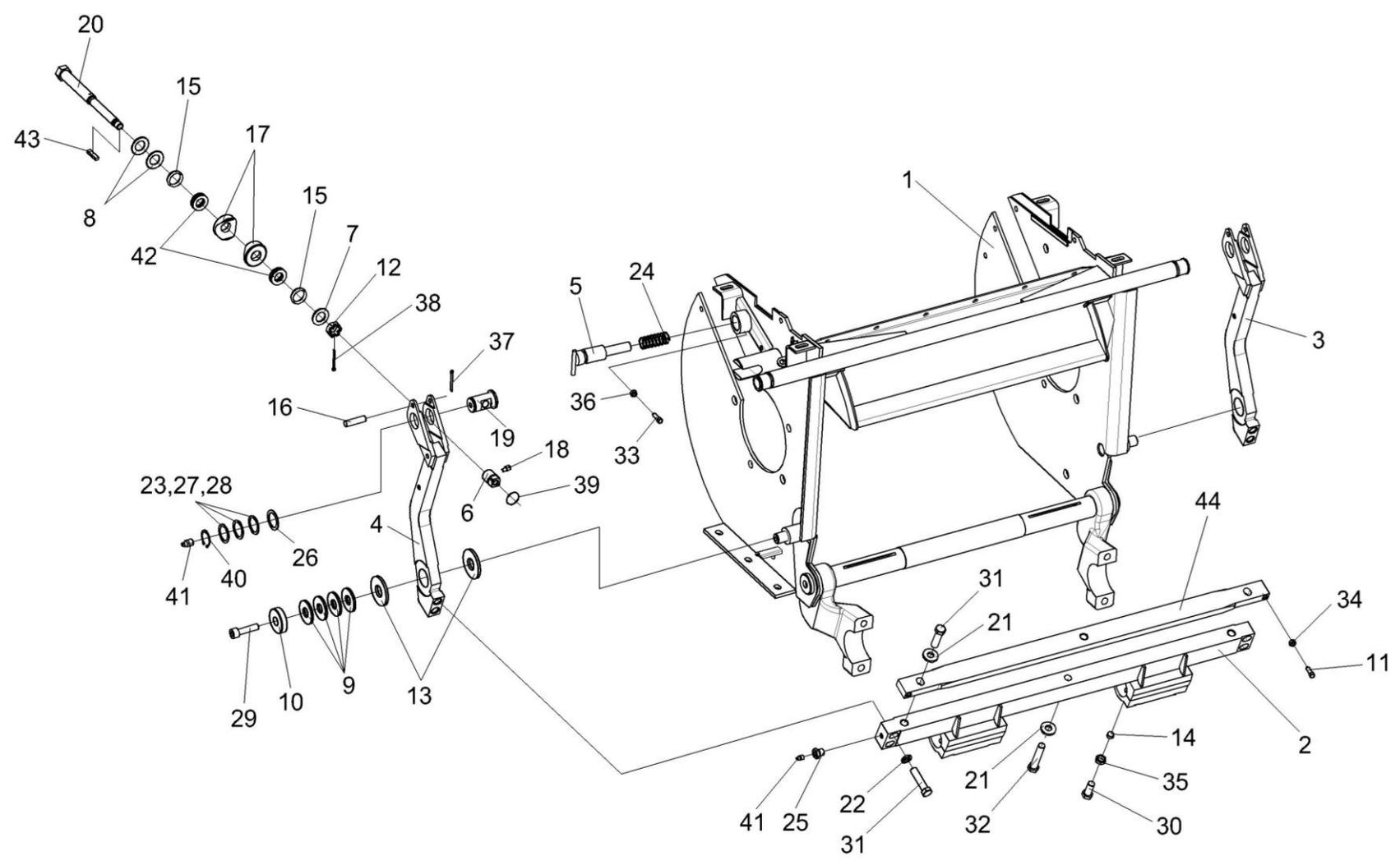
Рисунок 26 – Установка рычагов КВС-2-0117020 и КВС-2-0117020-01
