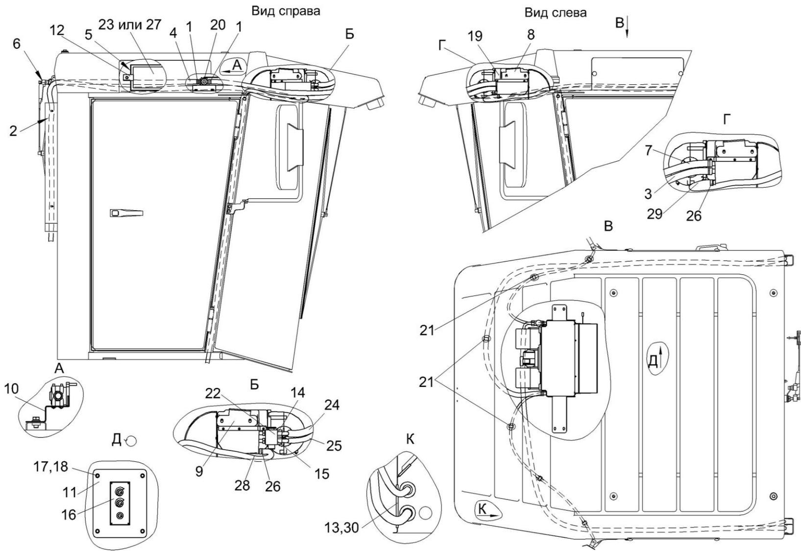
Рисунок 159 – Установка испарителя КВС-2-0121050
