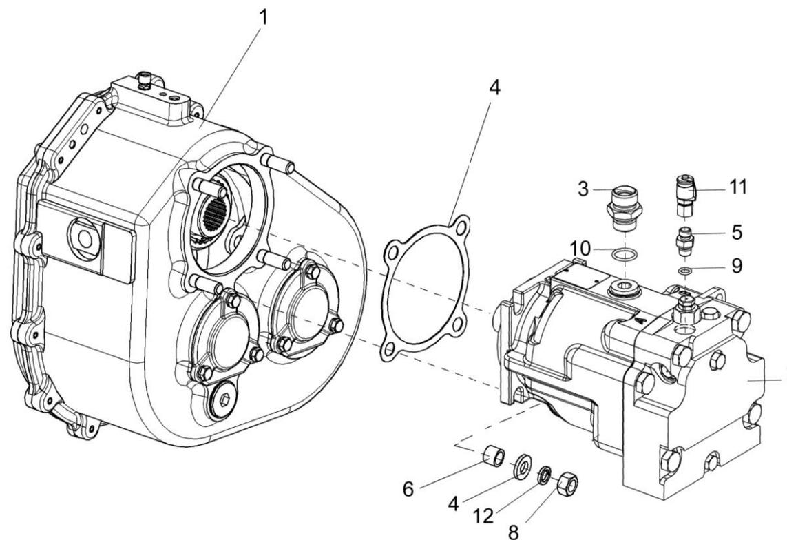
Рисунок 18 – Установка гидромотора привода питающего аппарата КВС-2-0604210
