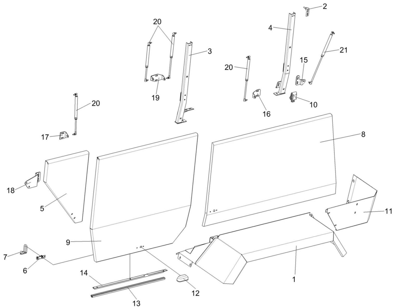
Рисунок 160 – Установка капотов КВС-2-0160000-02 (лист 1)
