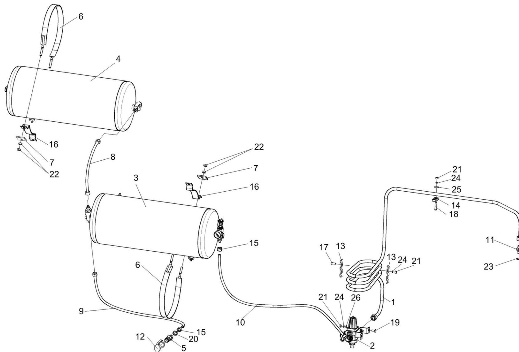
Рисунок 205 – Пневмосистема КВС-2-0800000
