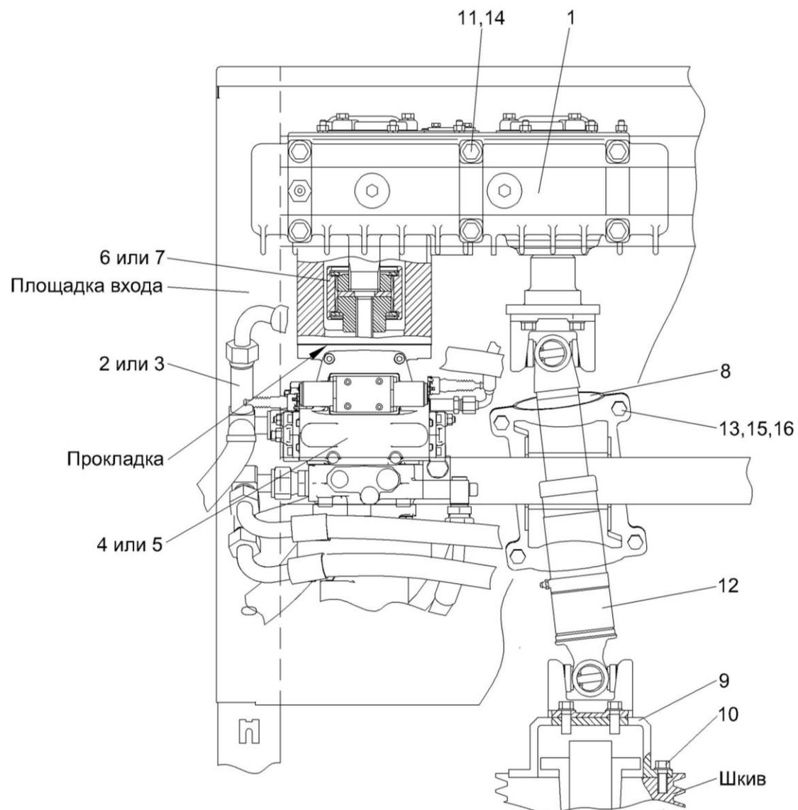
Рисунок 169 – Установка гидросистемы привода питающего аппарата и адаптеров
