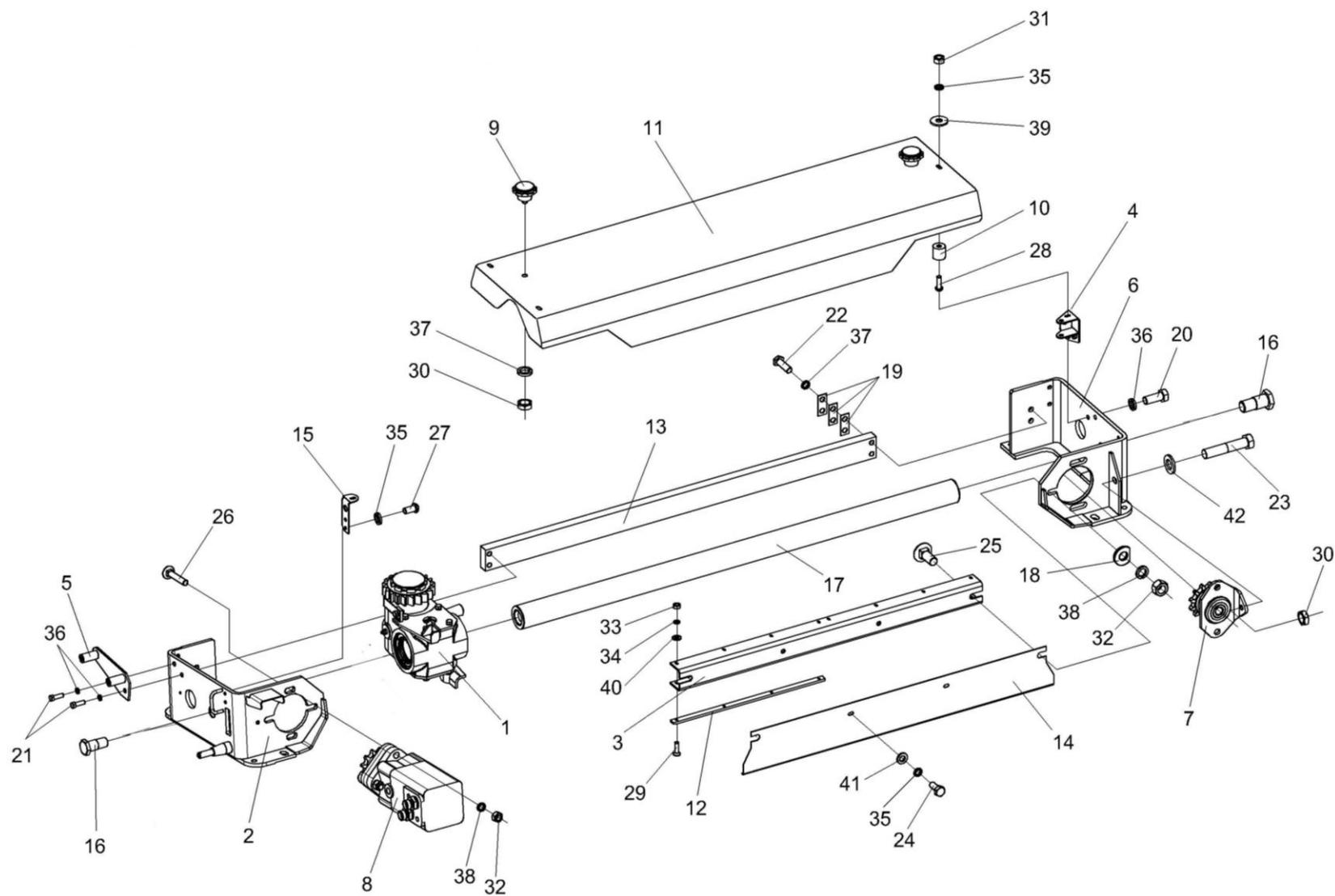
Рисунок 30 – Устройство заточное КВС-2-0116500
