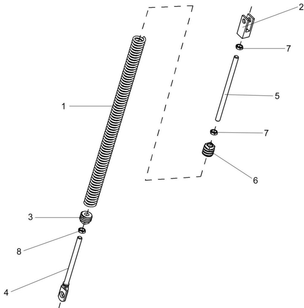
Рисунок 41 – Пружина КВС-1-0132090
