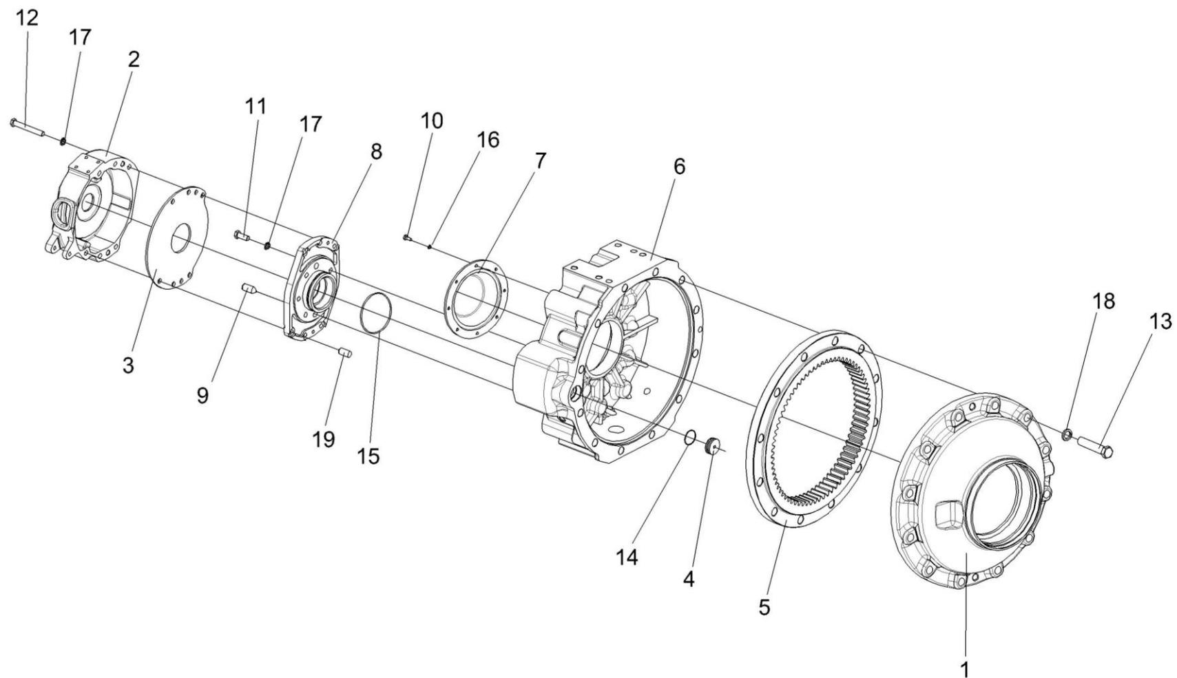
Рисунок 105 – Редуктор бортовой КЗК-10-0107200-03. Корпуса и крышки
