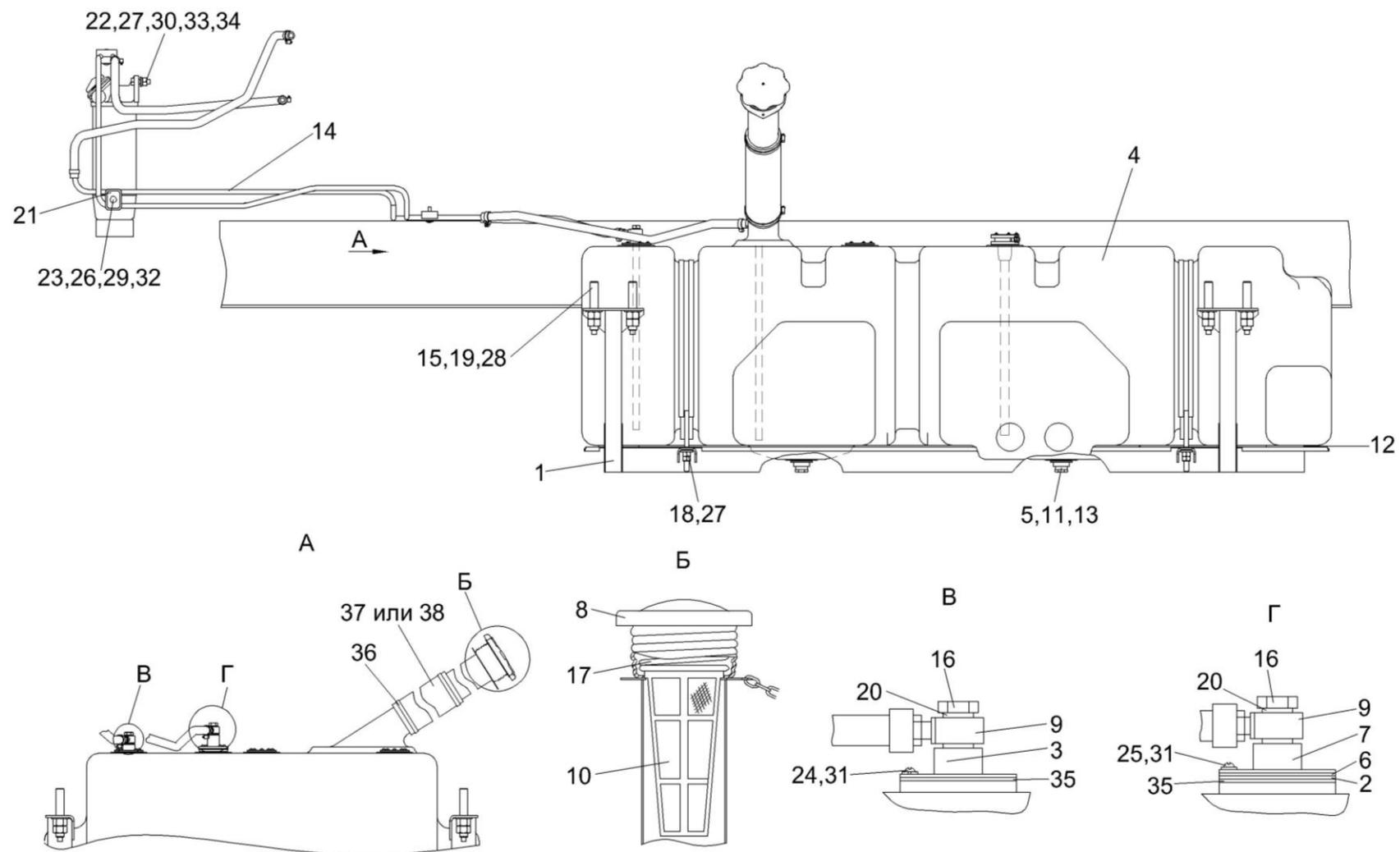
Рисунок 94 – Установка топливного оборудования KBC-2-01037000 (лист 1)
