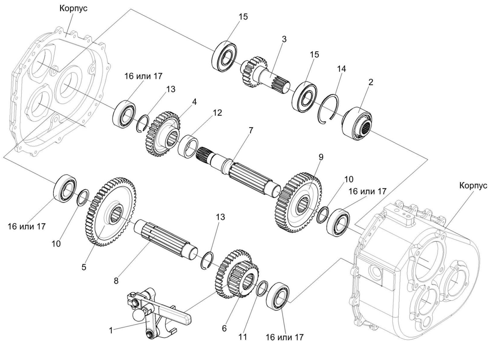
Рисунок 20 – Коробка передач КВС-2-0114100А. Валы и шестерни
