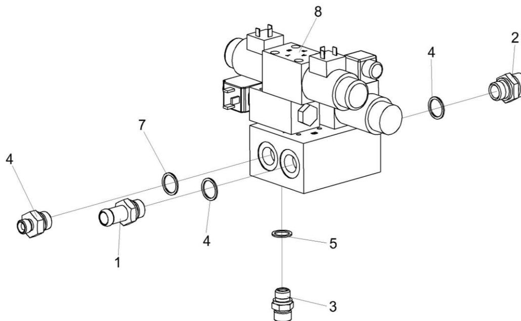
Рисунок 200 – Гидроблок навески КВС-5-0602300 и КВС-5-0602320
