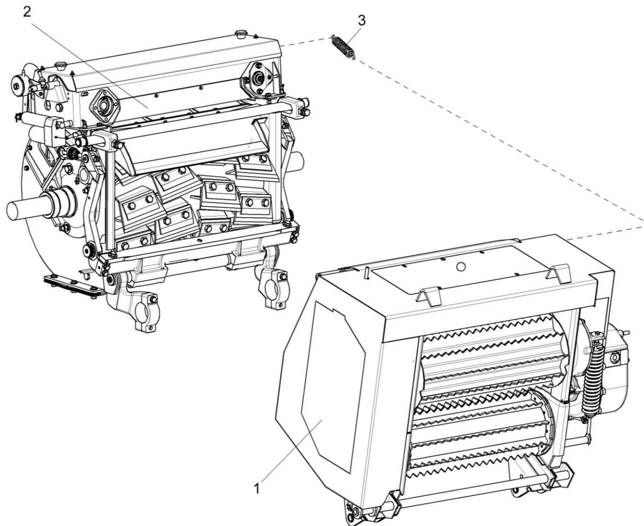
Рисунок 3 – Аппарат питающе-измельчающий КВС-2-0110000А-01
