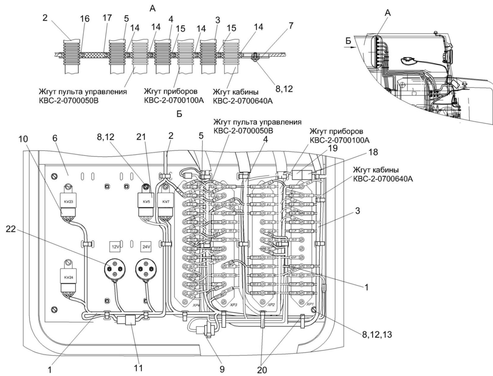
Рисунок 212 – Электрооборудование электрошкафа KBC-2-0702010B-01
