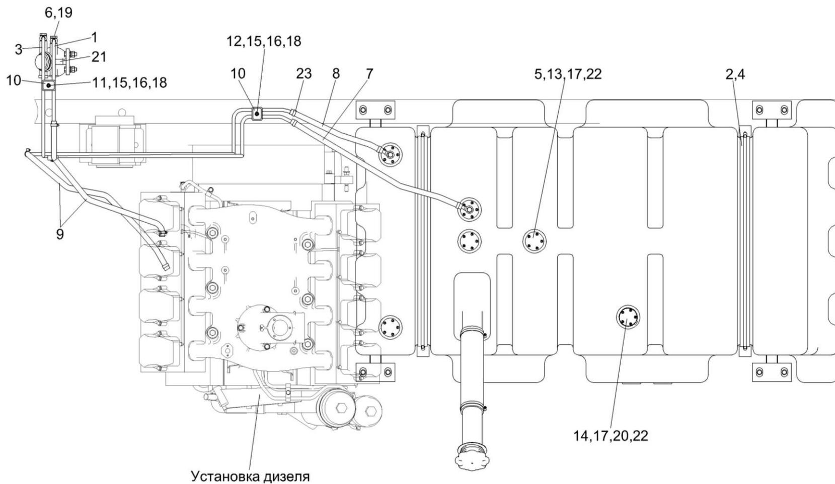
Рисунок 95 – Установка топливного оборудования KBC-2-01037000 (лист 2)
