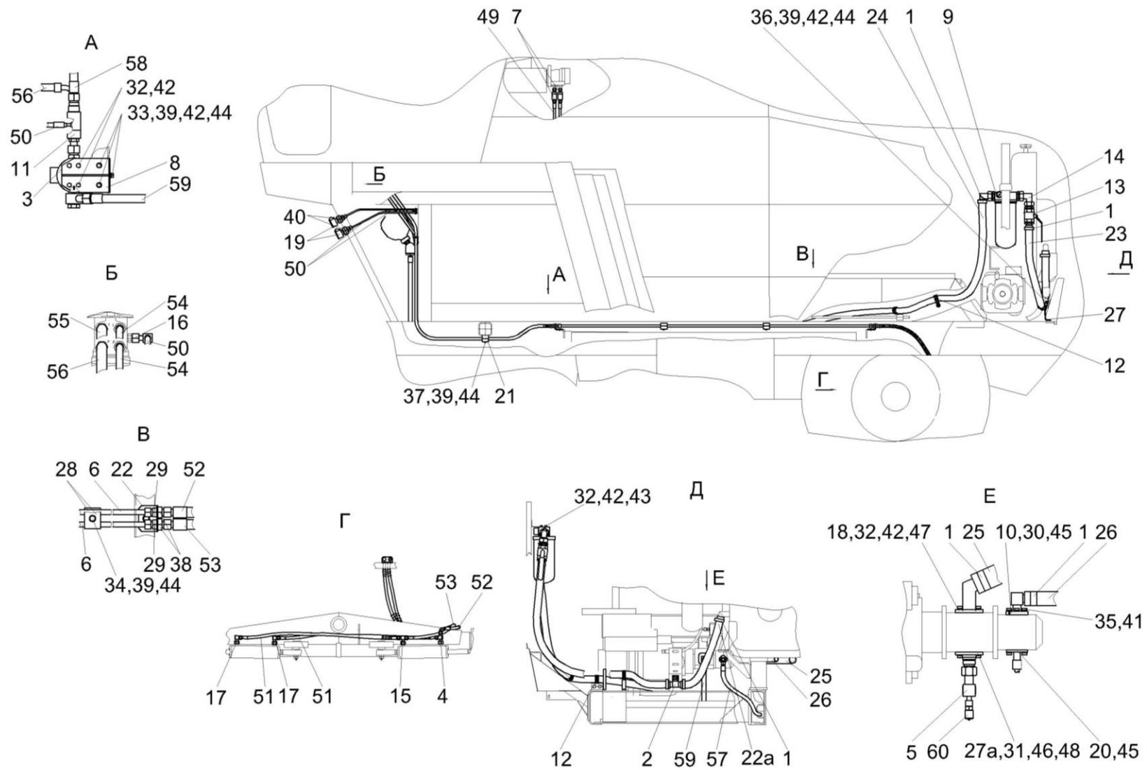
Рисунок 190 – Гидросистема рабочих органов и рулевого управления КВС-5-0602000 (лист 2)
