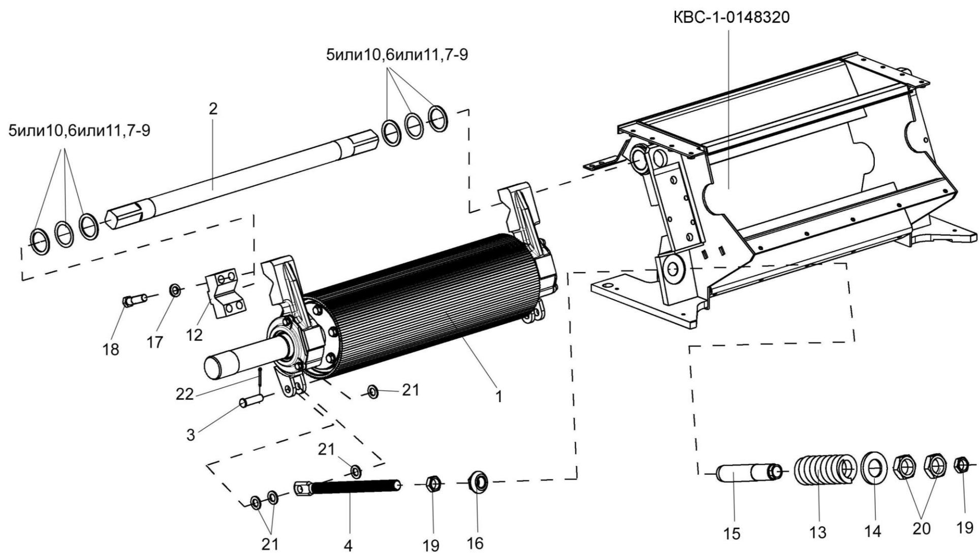
Рисунок 45 – Устройство доизмельчающее КВС-1-0148310 (установка нижнего вальца)
