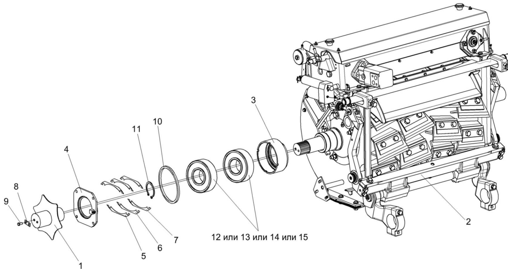
Рисунок 35 – Установка звезды KBC-2-0100460 на барабан измельчающего аппарата
