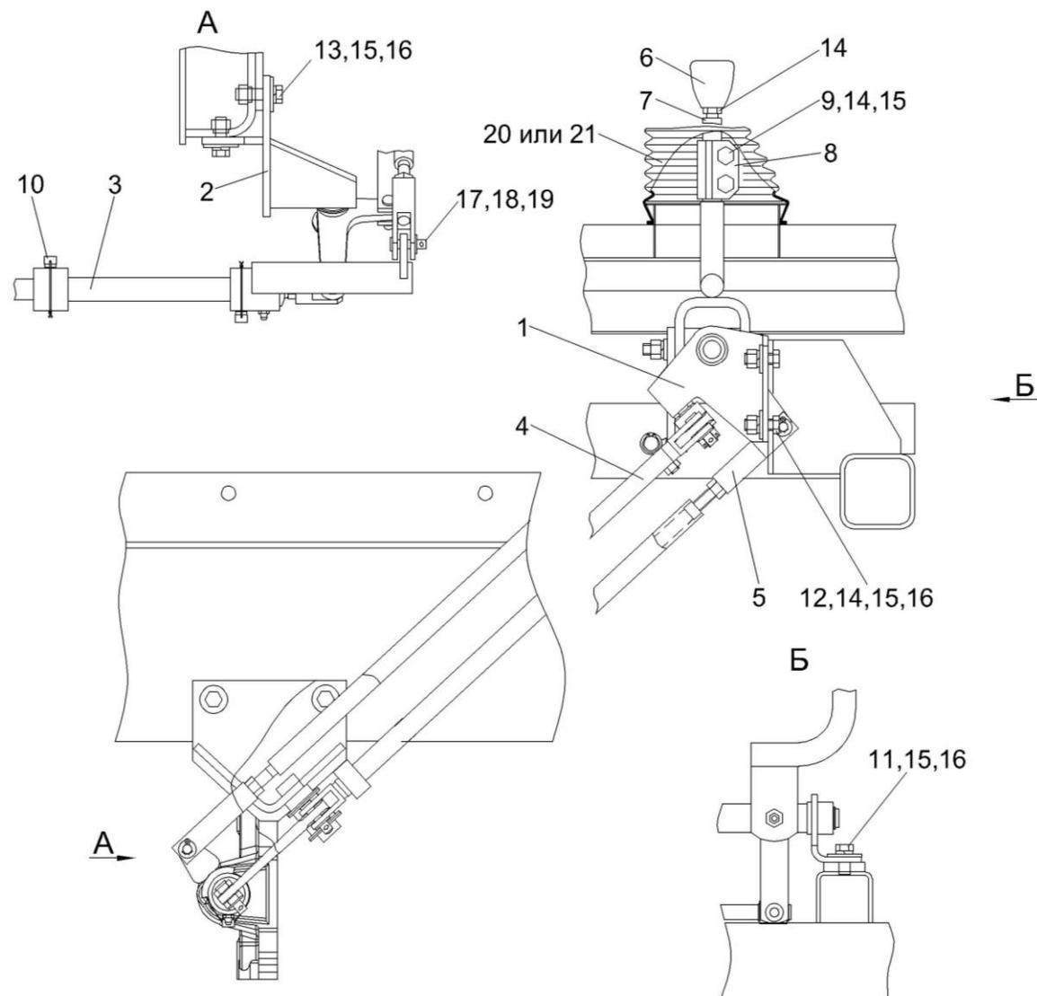
Рисунок 142 – Установка механизма управления коробкой диапазонов KBC-2-0129040
