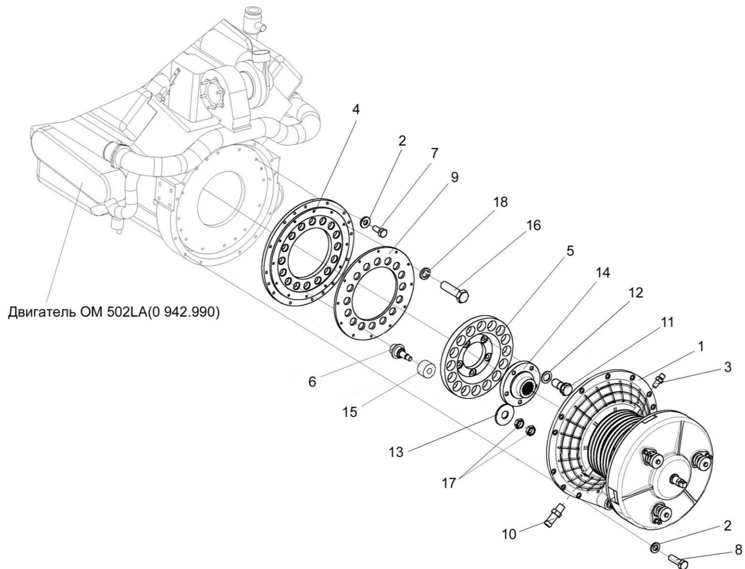
Рисунок 72 – Установка главного привода
