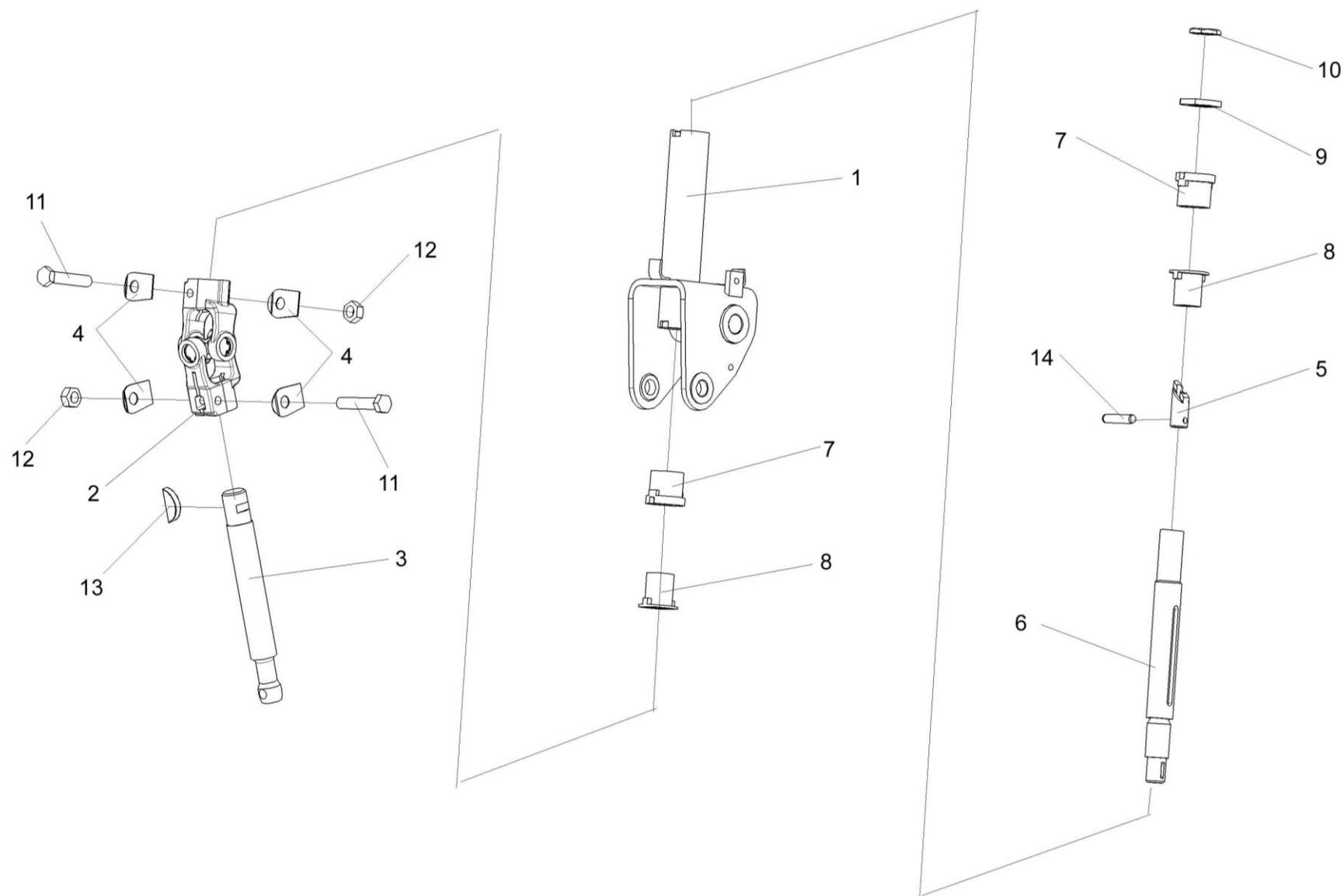
Рисунок 133 – Привод управления КЗС 0119600
