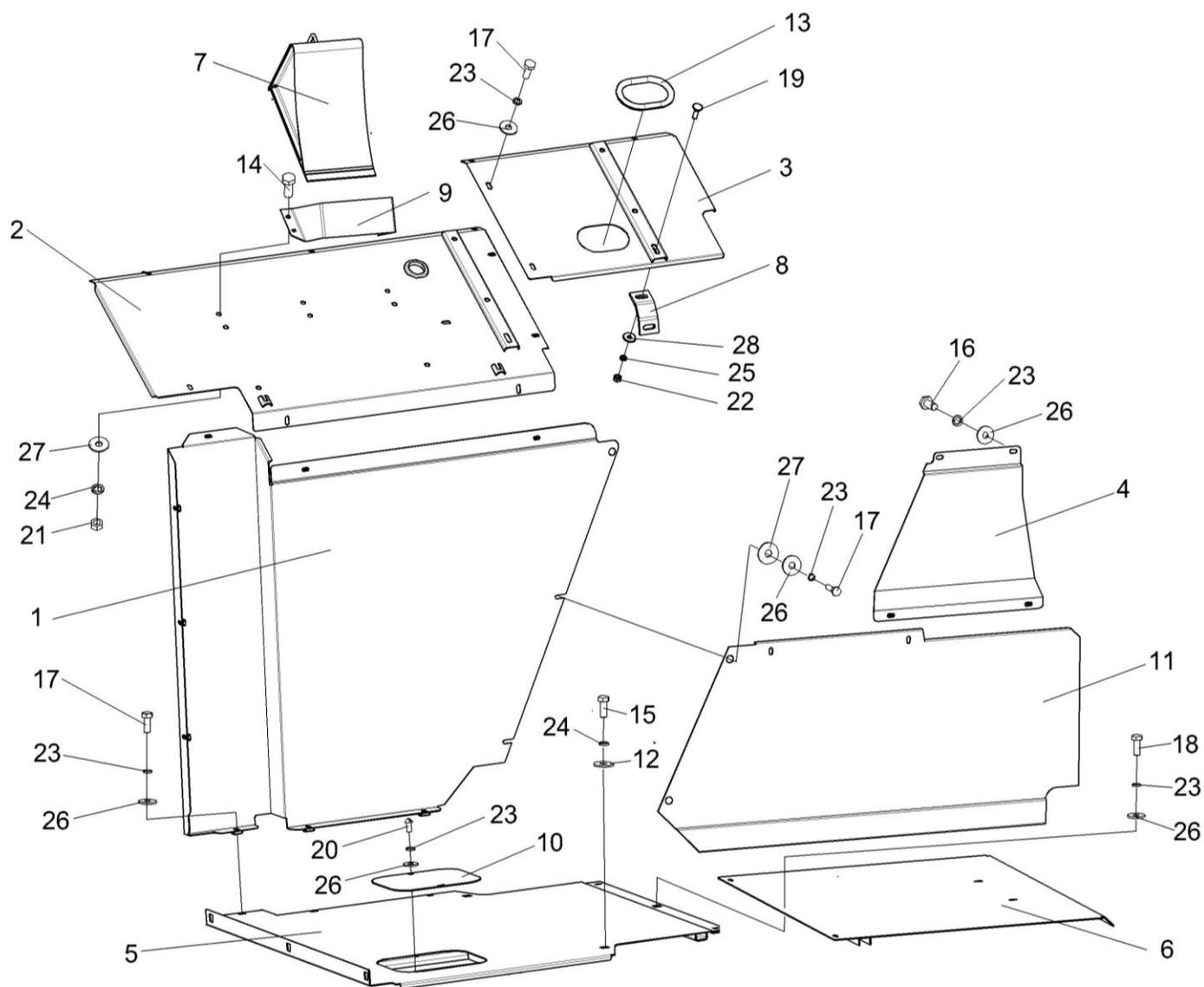
Рисунок 167 – Установка настилов и ограждений КВС-2-0169000
