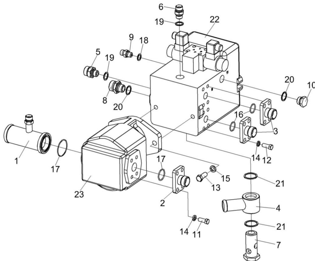
Рисунок 182 – Гидронасос двухсекционный КВС-5-0624340
