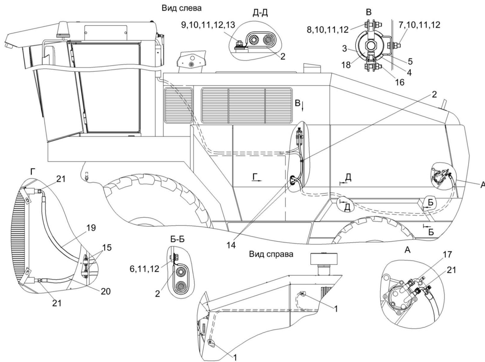
Рисунок 158 – Установка климатическая КВС-2-0121000Б
