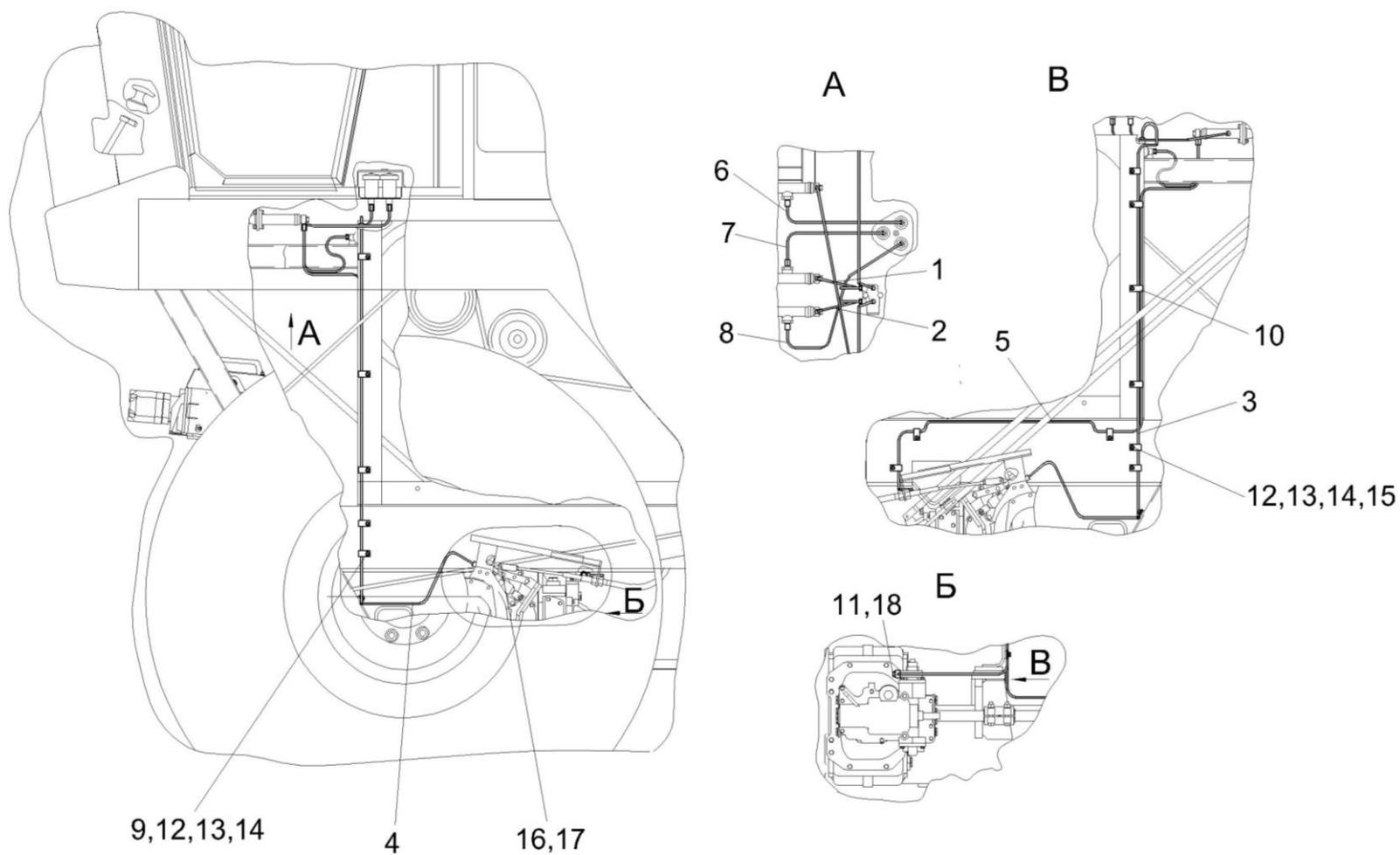
Рисунок 146 – Установка трубопроводов и стояночных тормозов KBC-1-0129100
