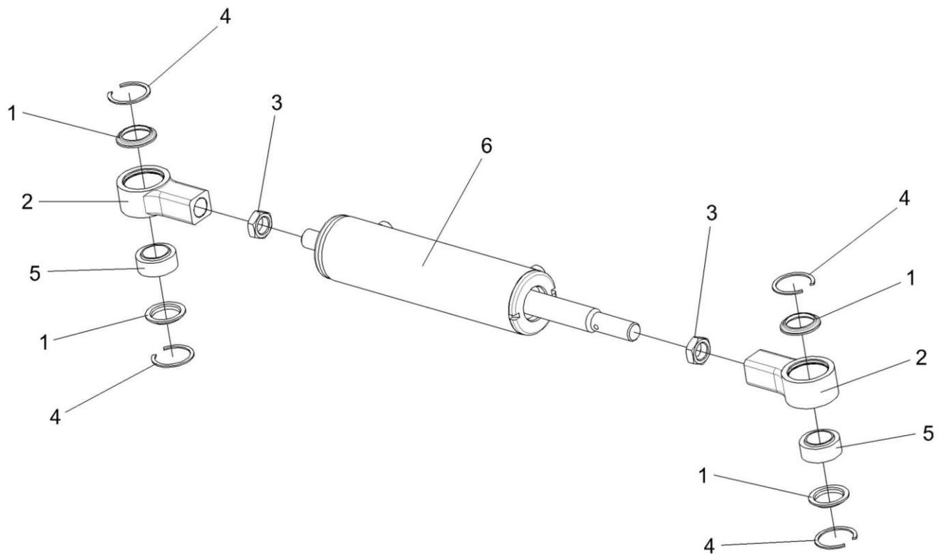
Рисунок 116 – Гидроцилиндр УЭС-7-0109200
