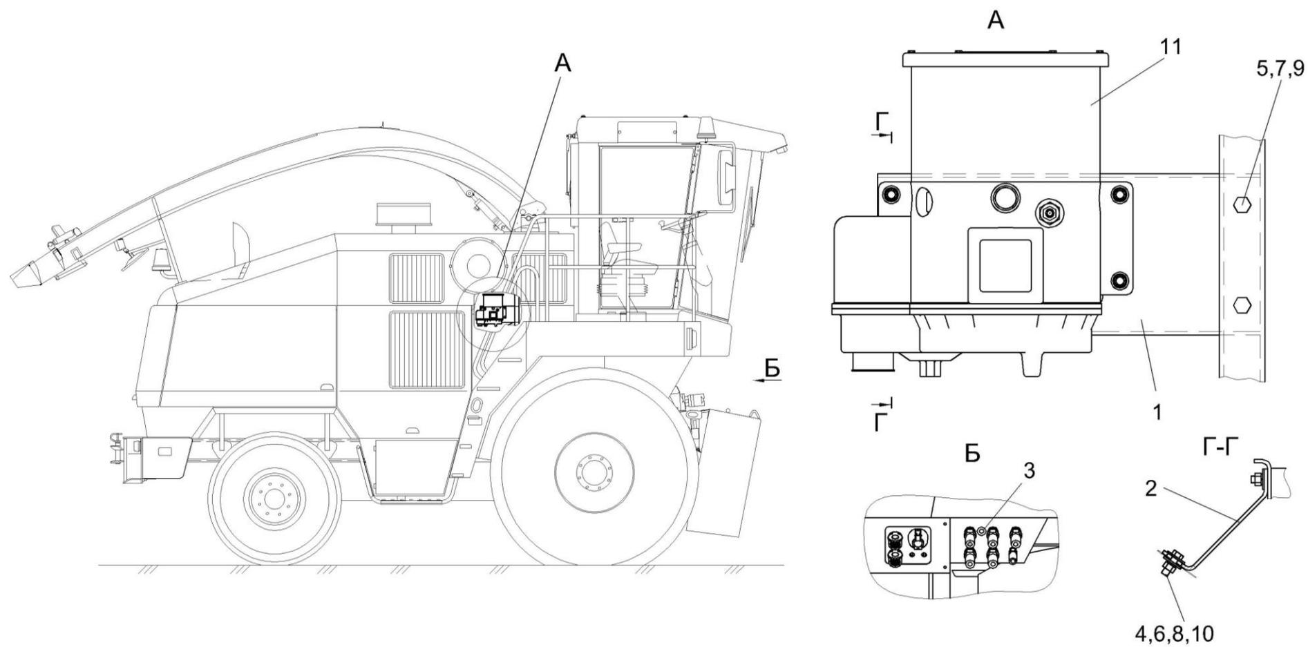
Рисунок 215 – Установка централизованной системы смазки KBC-2-0900700
