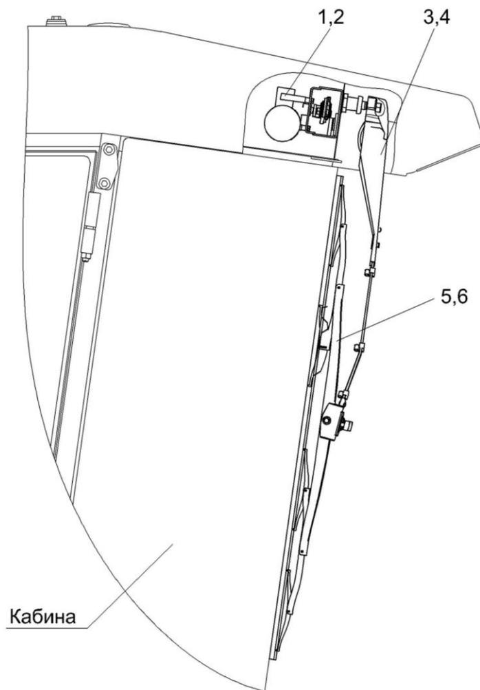
Рисунок 155 – Установка стеклоочистителя КЗК-12-0120810 или КЗК-12-0120810-01
