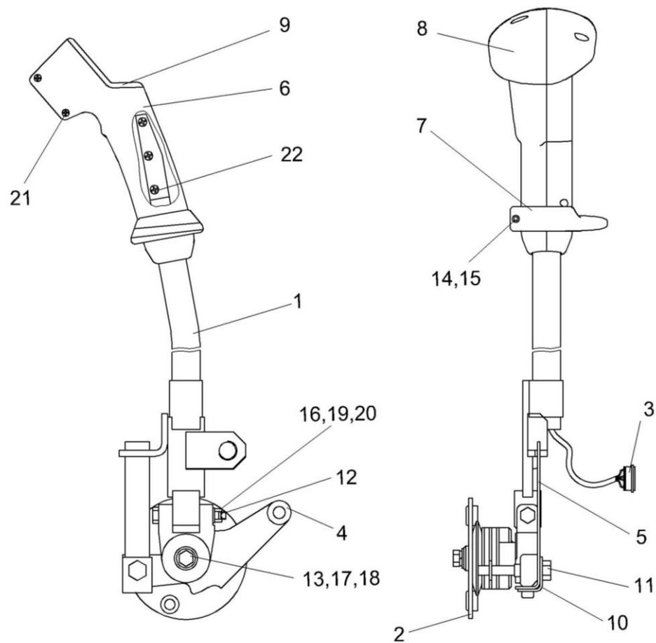
Рисунок 126 – Привод КВС-5-0129550
