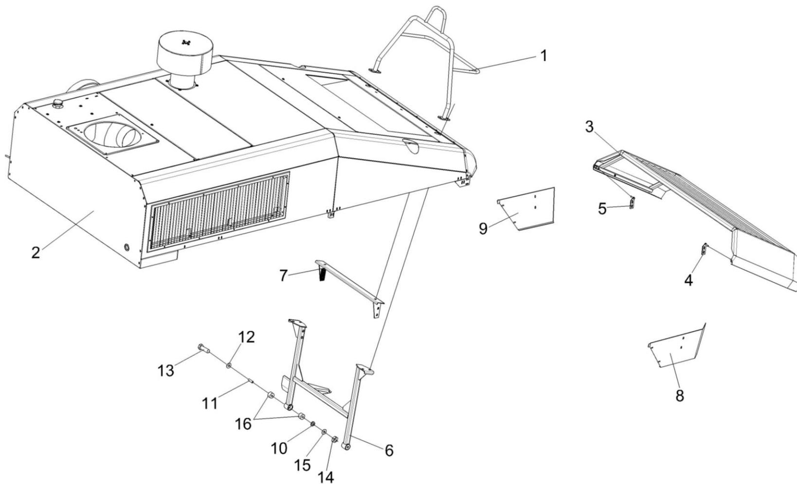
Рисунок 162 – Установка капотов КВС-2-0160000-02 (лист 3)
