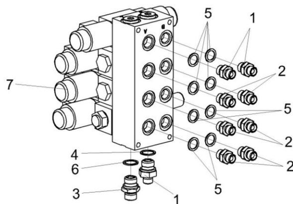
Рисунок 199 – Гидроблок четырехсекционный КВС-2-0602310-01
