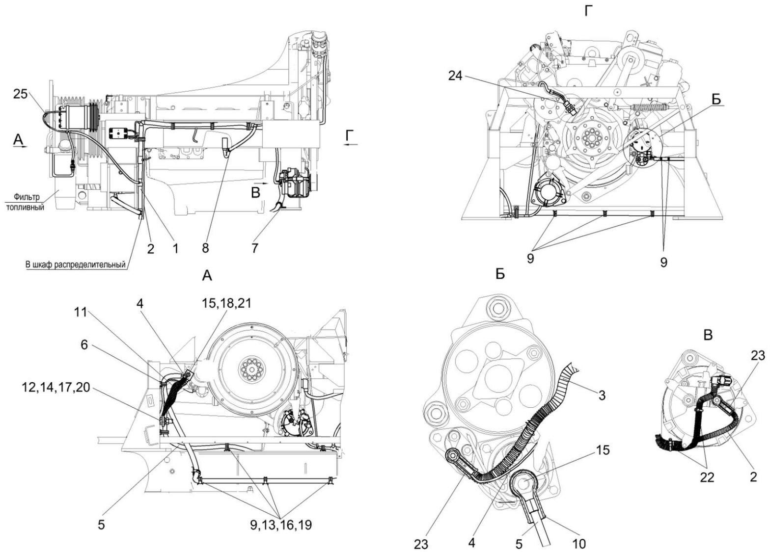
Рисунок 69 – Электрооборудование дизеля OM 502LA KBC-2-0100000-01
