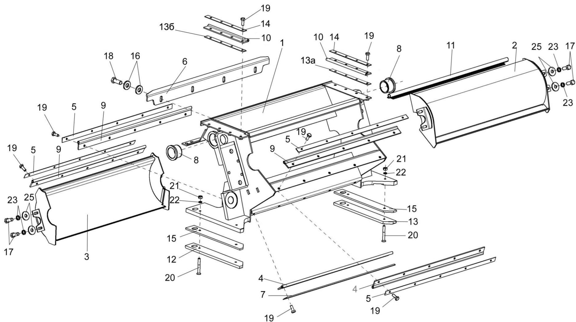
Рисунок 43 – Устройство доизмельчающее KBC-1-0148310 (установка кожухов)
