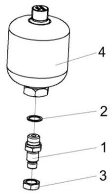
Рисунок 203 – Пневмогидроаккумулятор КВС-5-0602400
