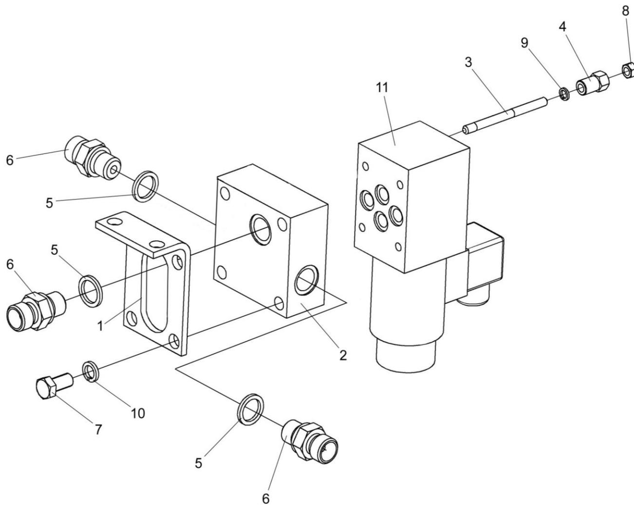
Рисунок 188 – Гидроблок включения главного привода КВС-1-0601220А
