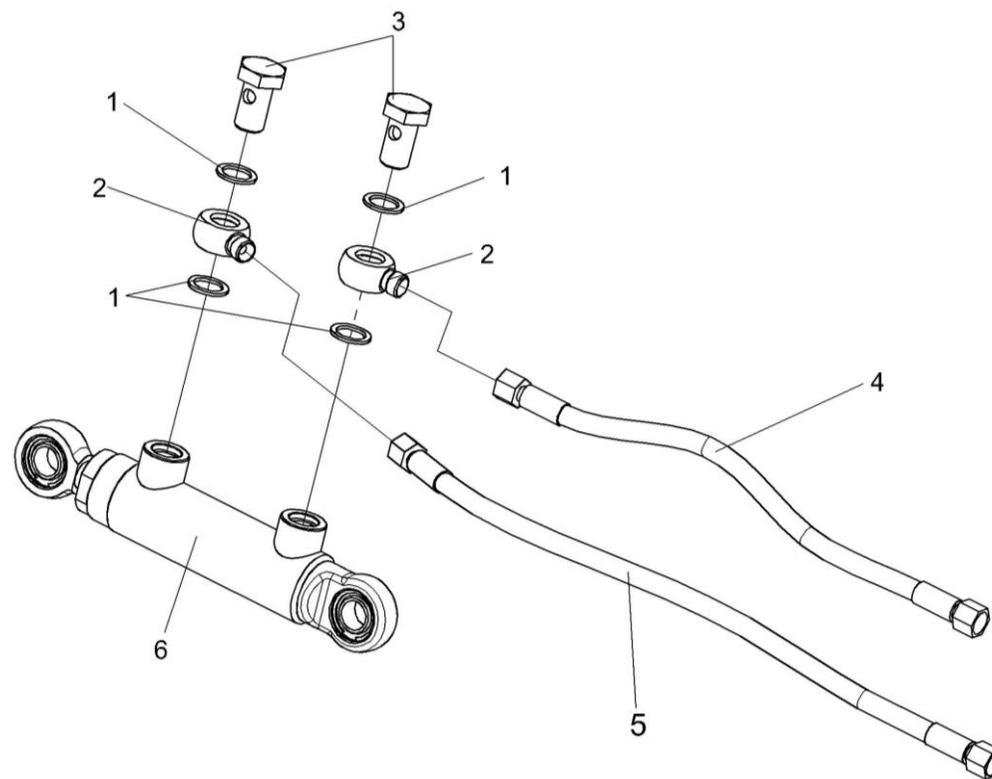
Рисунок 191 – Гидроцилиндр КВС-1-0602120
