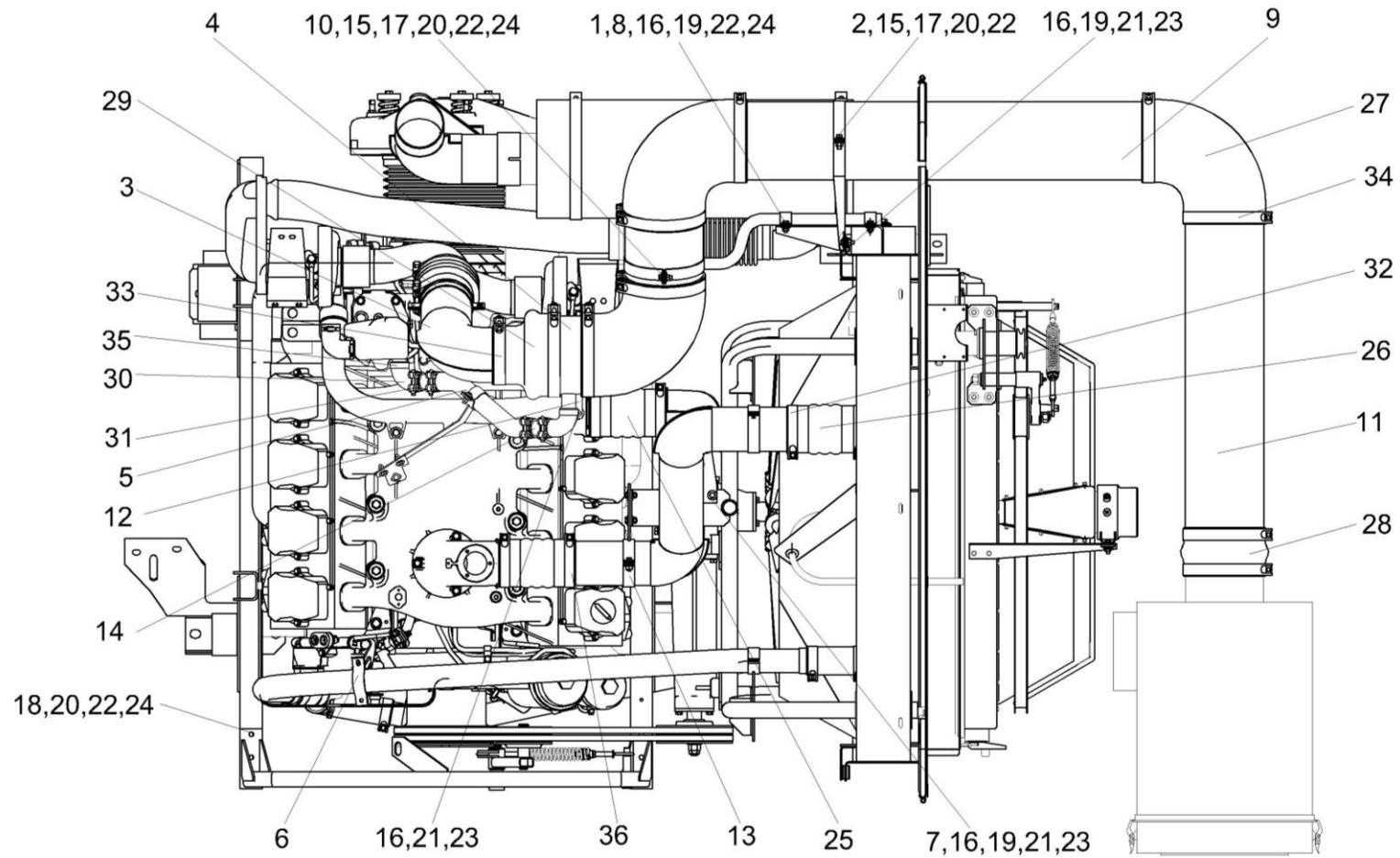
Рисунок 68 – Установка дизеля OM 502LA КВС-2-0150000В (лист 4)
