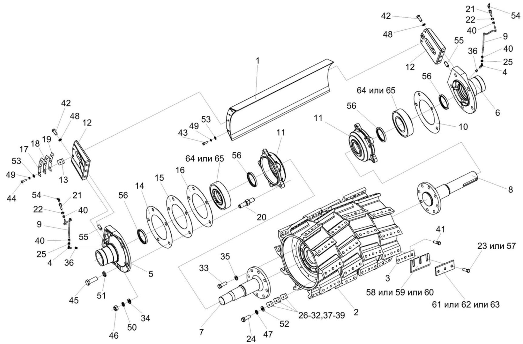
Рисунок 25 – Установка барабана КВС-2-0115430
