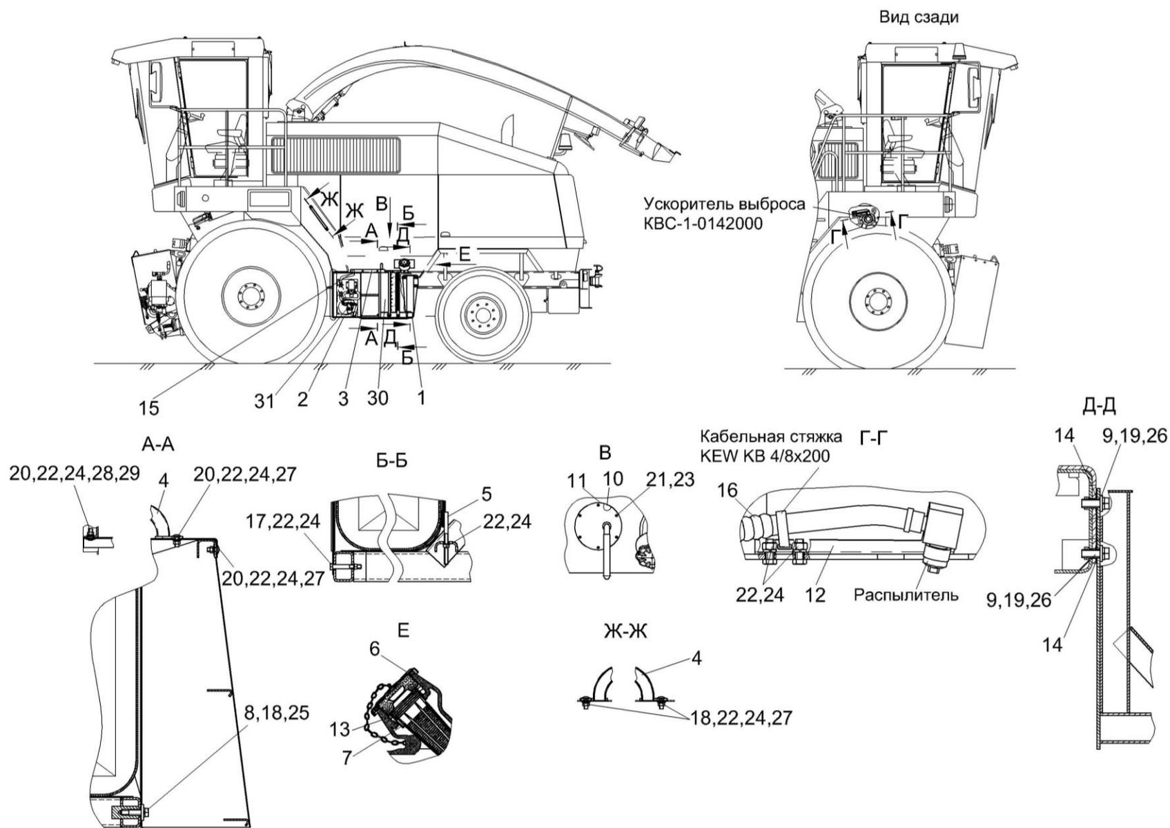
Рисунок 216 – Установка ОВК КВС-2-0900000А
