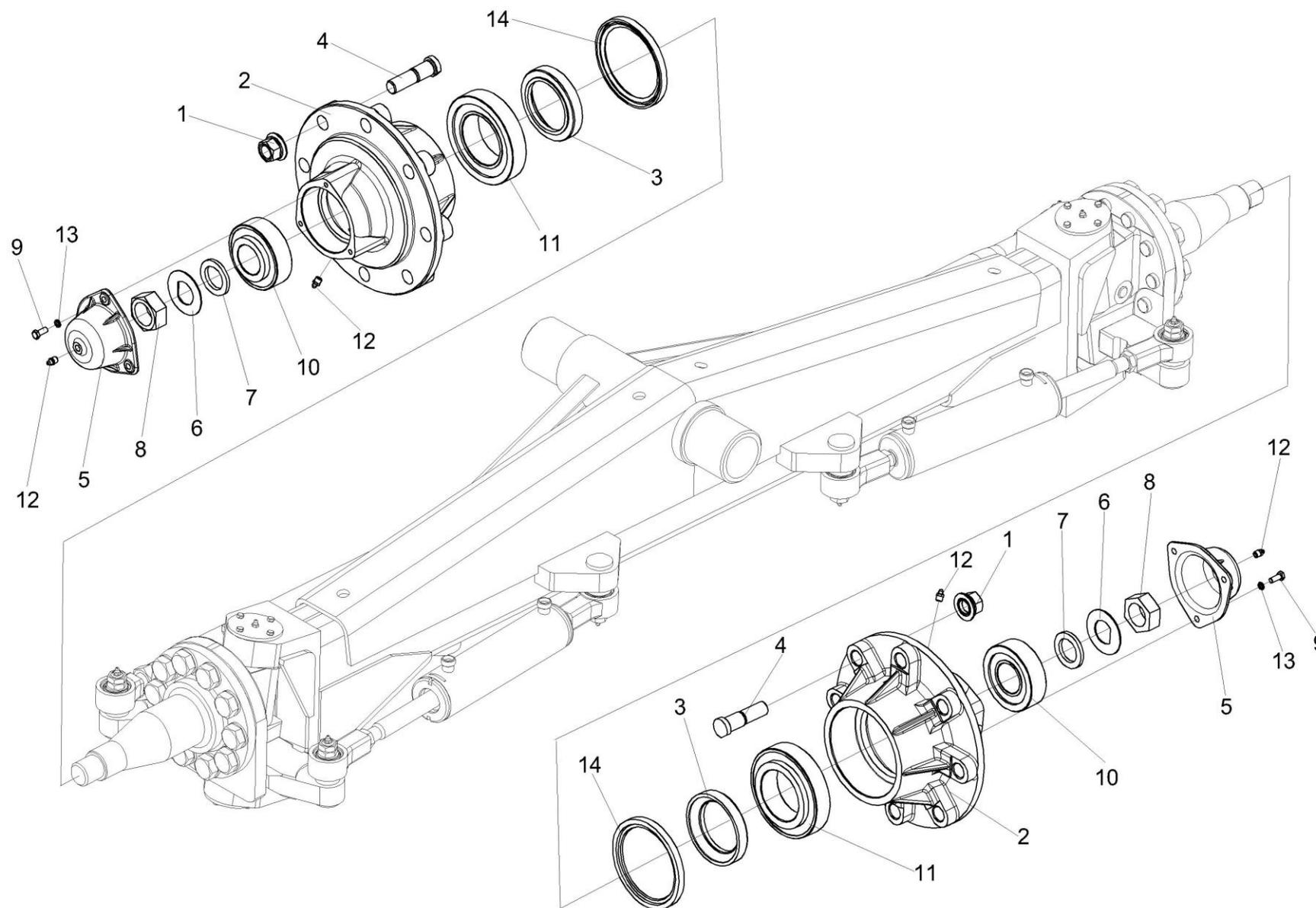
Рисунок 115 – Мост управляемых колес КВС-2-0109000 (установка ступиц)
