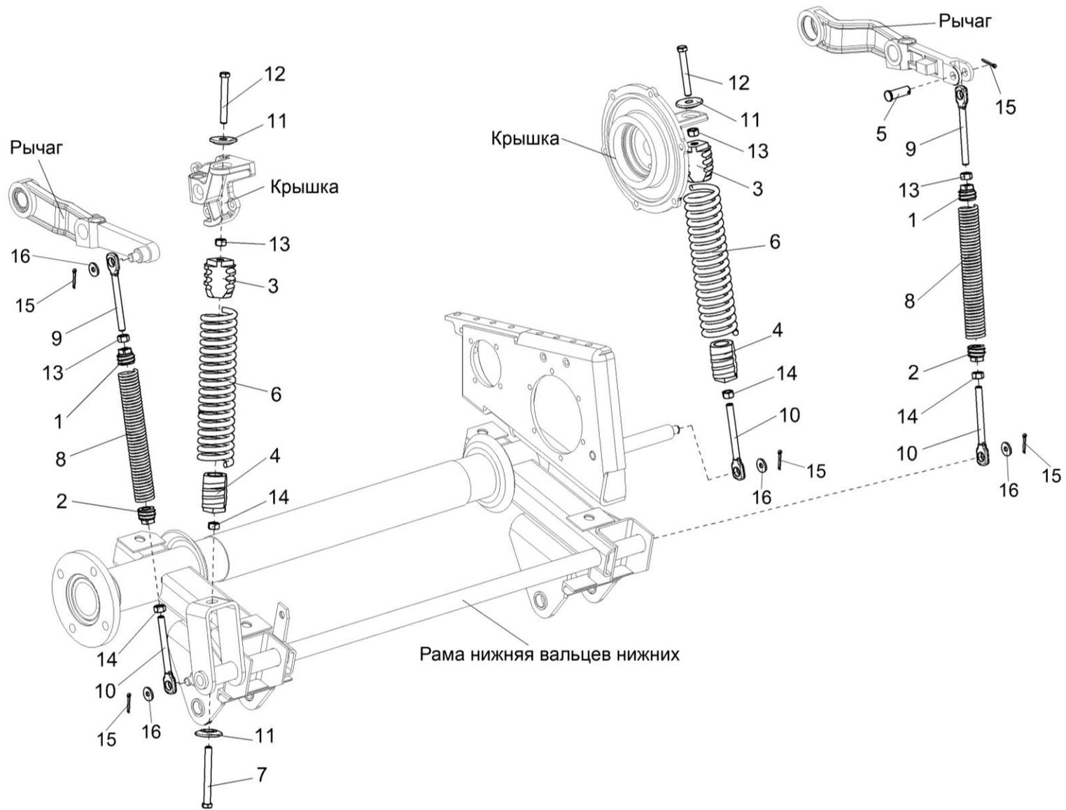
Рисунок 7 – Пружины аппарата питающего
