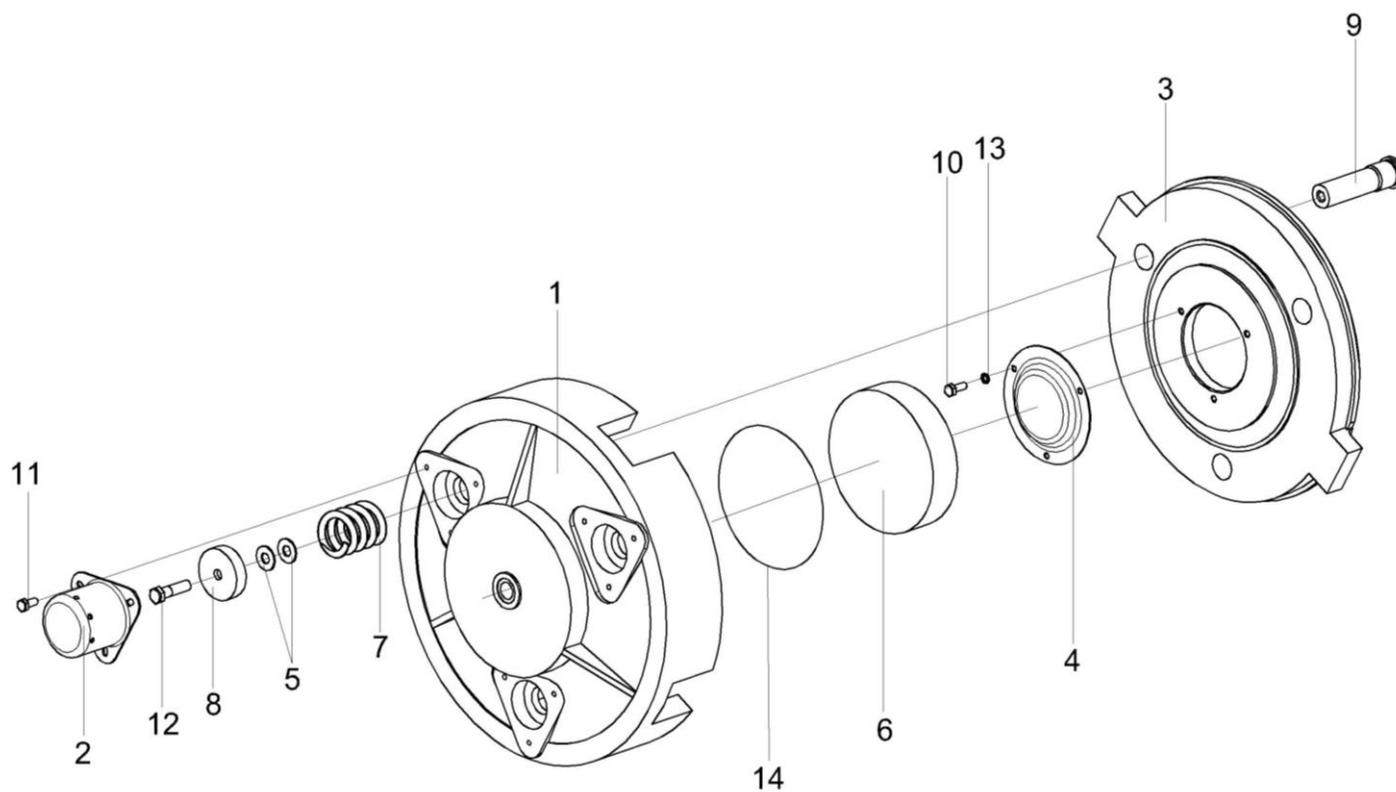
Рисунок 75 – Механизм нажимной КВК 0151040
