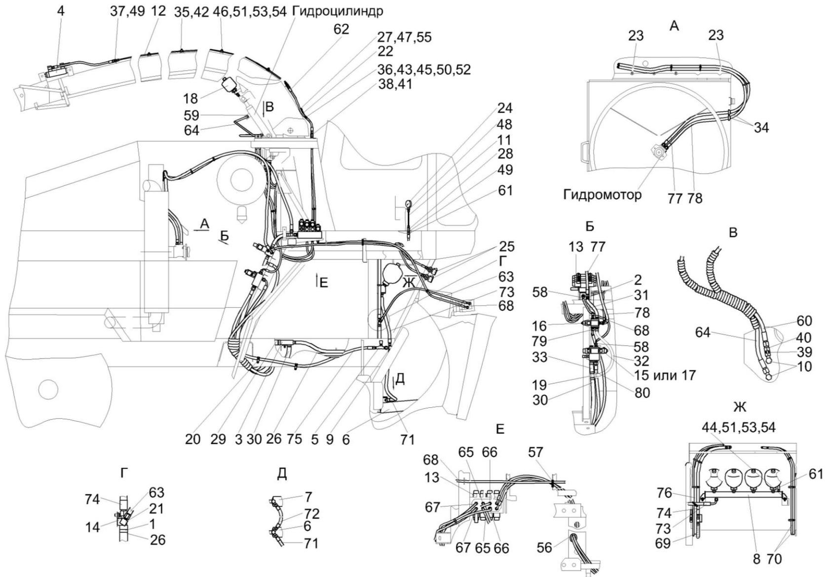
Рисунок 189 – Гидросистема рабочих органов и рулевого управления КВС-5-0602000 (лист 1)
