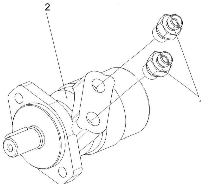
Рисунок 84 – Гидромотор воздухозаборника KBC-5-0602100
