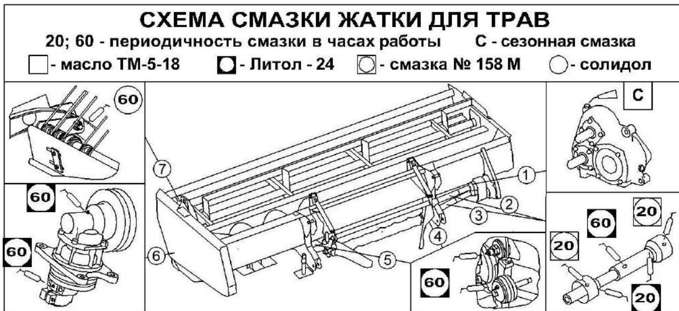
Рисунок 3.2 – Схема смазки жатки
