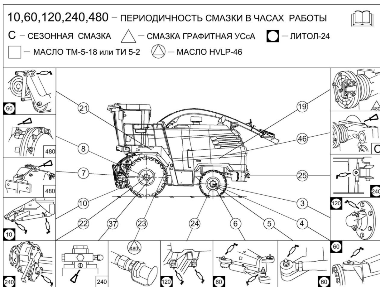
Рисунок 3.16 – Схема смазки комбайна (вид слева)
