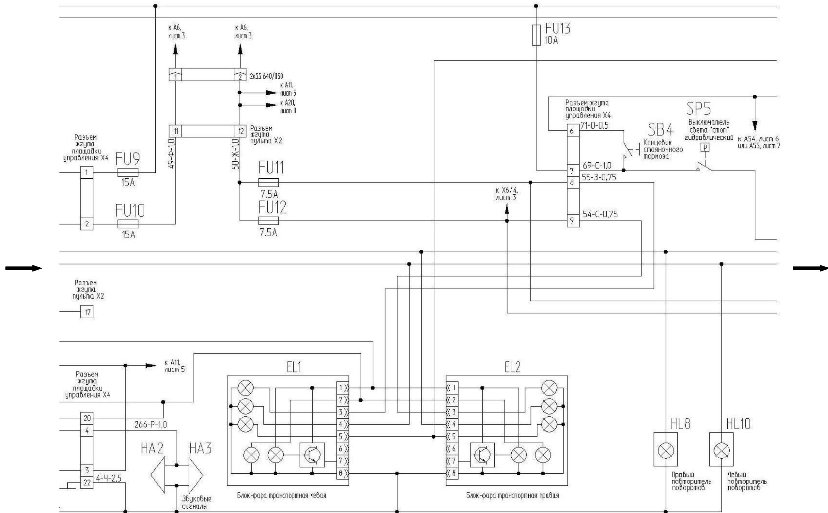
Рисунок Б.2 – Схема электрическая принципиальная комбайна (лист 2.2)
