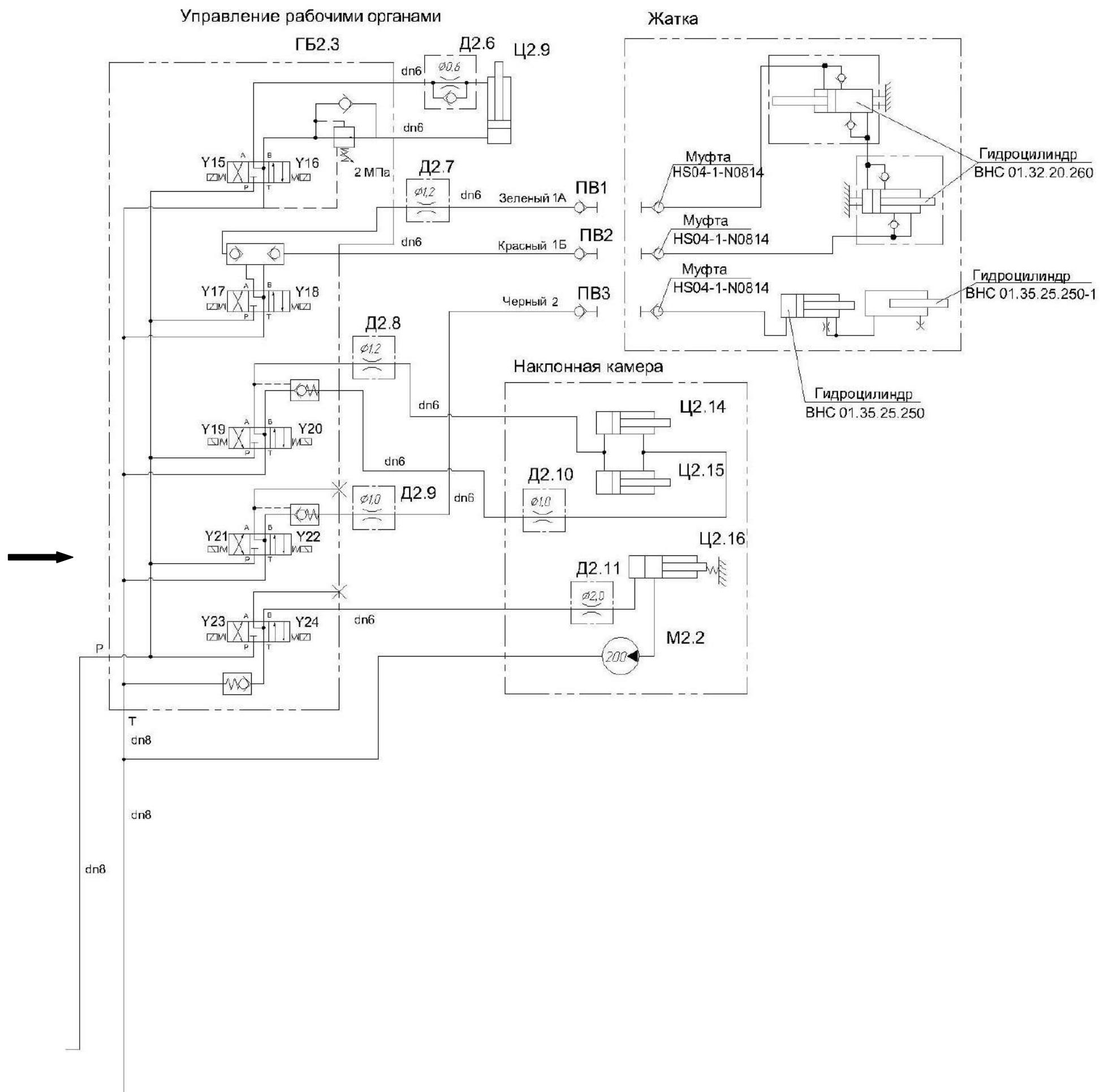
ГБ2.1, ГБ2.2, ГБ2.3 – гидроблоки; Д2.2, Д2.4, Д2.3, Д2.11, Д2.9, Д2.10, Д2.1, Д2.12, Д2.6 – дроссели с обратным клапаном; Д2.7, Д2.8, Д2.5 – ниппели; Кр2.1 – кран шаровой ММ рычажный;
