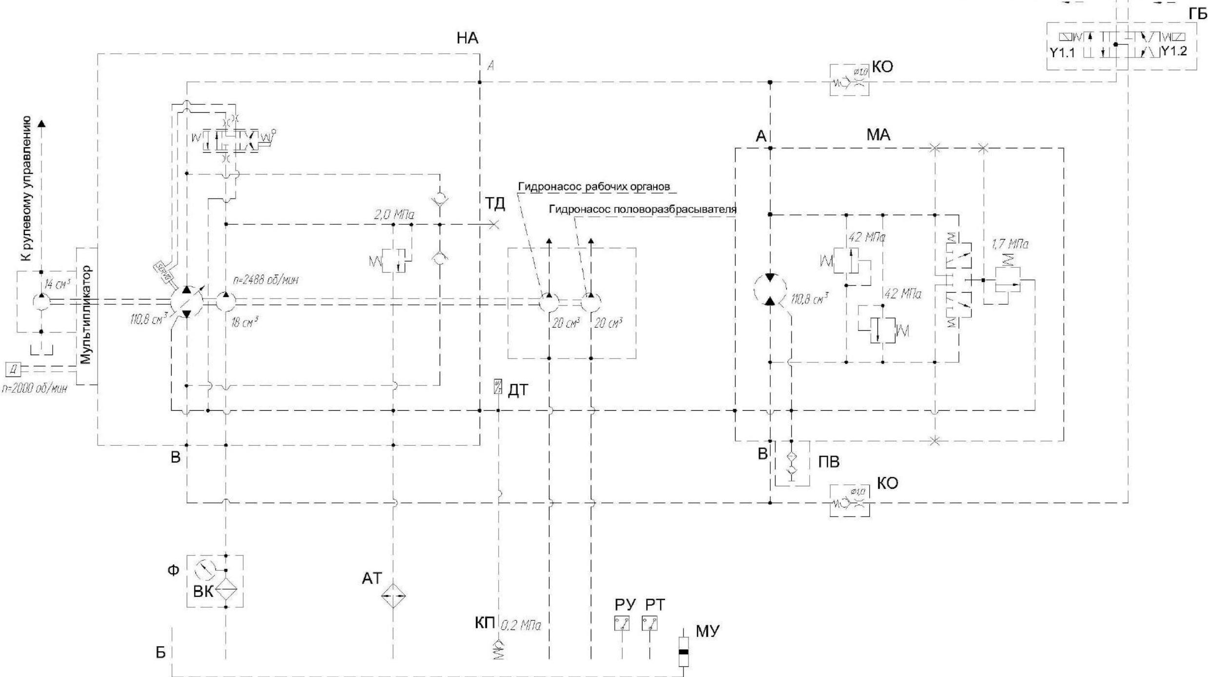
АТ – масляная секция радиатора; Б – бак масляный; ВК – вакуумметр; ГБ – гидроблок; ДТ - датчик указателя температуры жидкости ДУТЖ-01; КО – клапан обратный; КП – гидроклапан обратный; МА – гидромотор аксиально – поршневой нерегулируемый; МУ – указатель уровня масла; НА – тандем насосов; ПВ – полумуфта внутренняя; РТ – датчик аварийной температуры жидкости ДАТЖ-04; РУ – датчик – гидросигнализатор; ТД – соединение резьбовое с колпачком; Ф – фильтр
