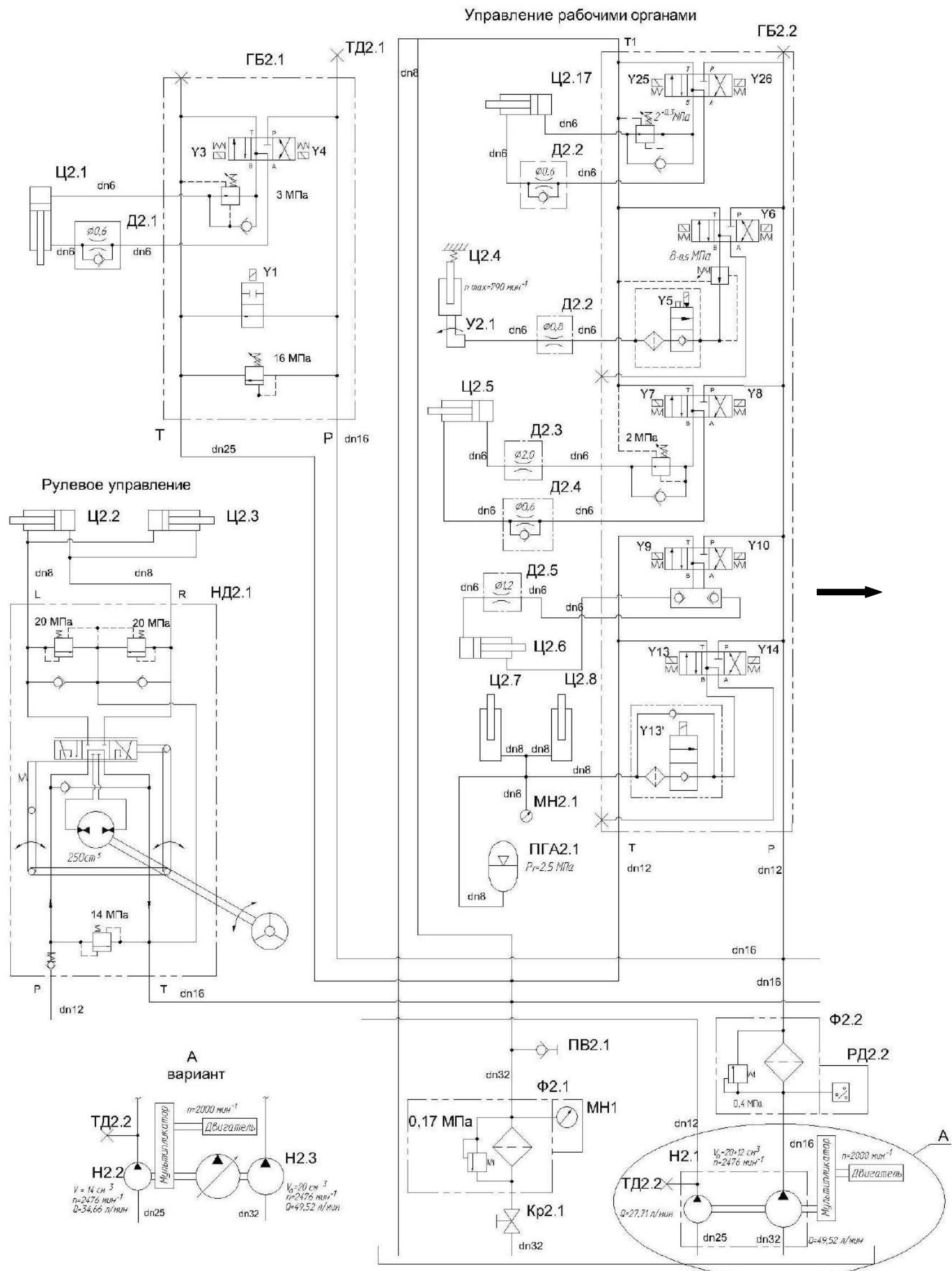
ГБ2.1, ГБ2.2, ГБ2.3 – гидроблоки; Д2.2, Д2.4, Д2.3, Д.2.11, Д.2.9, Д.2.10, Д.2.1, Д.2.12, Д.2.6 – дроссели с обратным клапаном; Д2.7, Д2.8, Д2.5 – ниппели; Кр2.1 – кран шаровой ММ рычажный;
