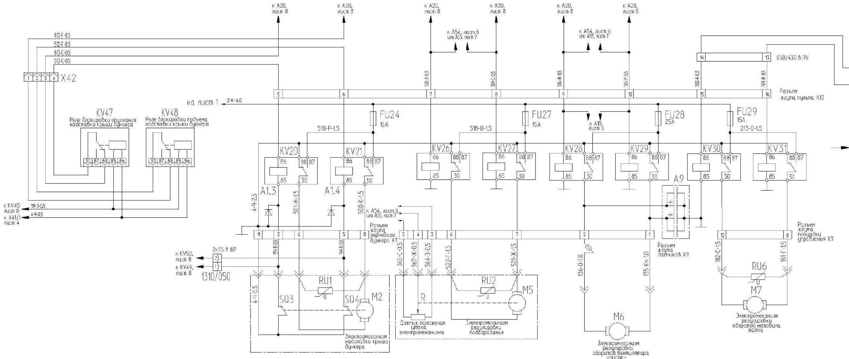
Рисунок Б.5 – Схема электрическая принципиальная комбайна (лист 5.1)
