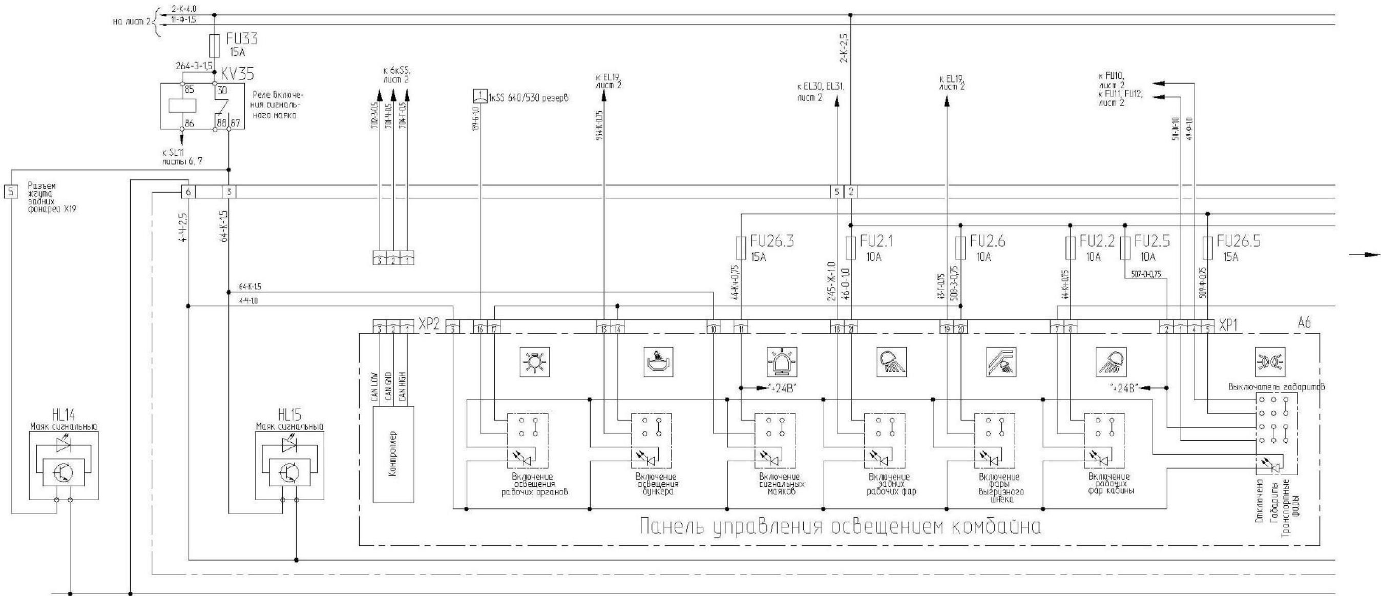
Рисунок Б.3 – Схема электрическая принципиальная комбайна (лист 3.1)
