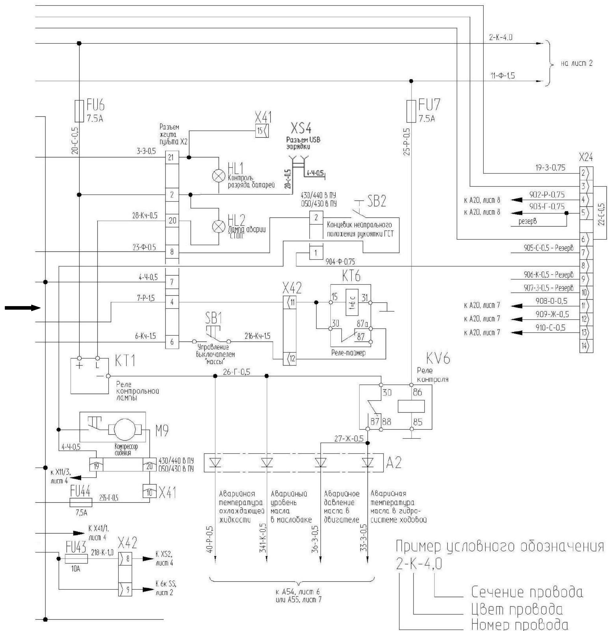
Рисунок Б.1 – Схема электрическая принципиальная комбайна (лист 1.2)
