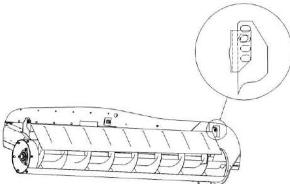
Рисунок 2.13 – Регулировка ограждения над горизонтальным шнеком бункера
