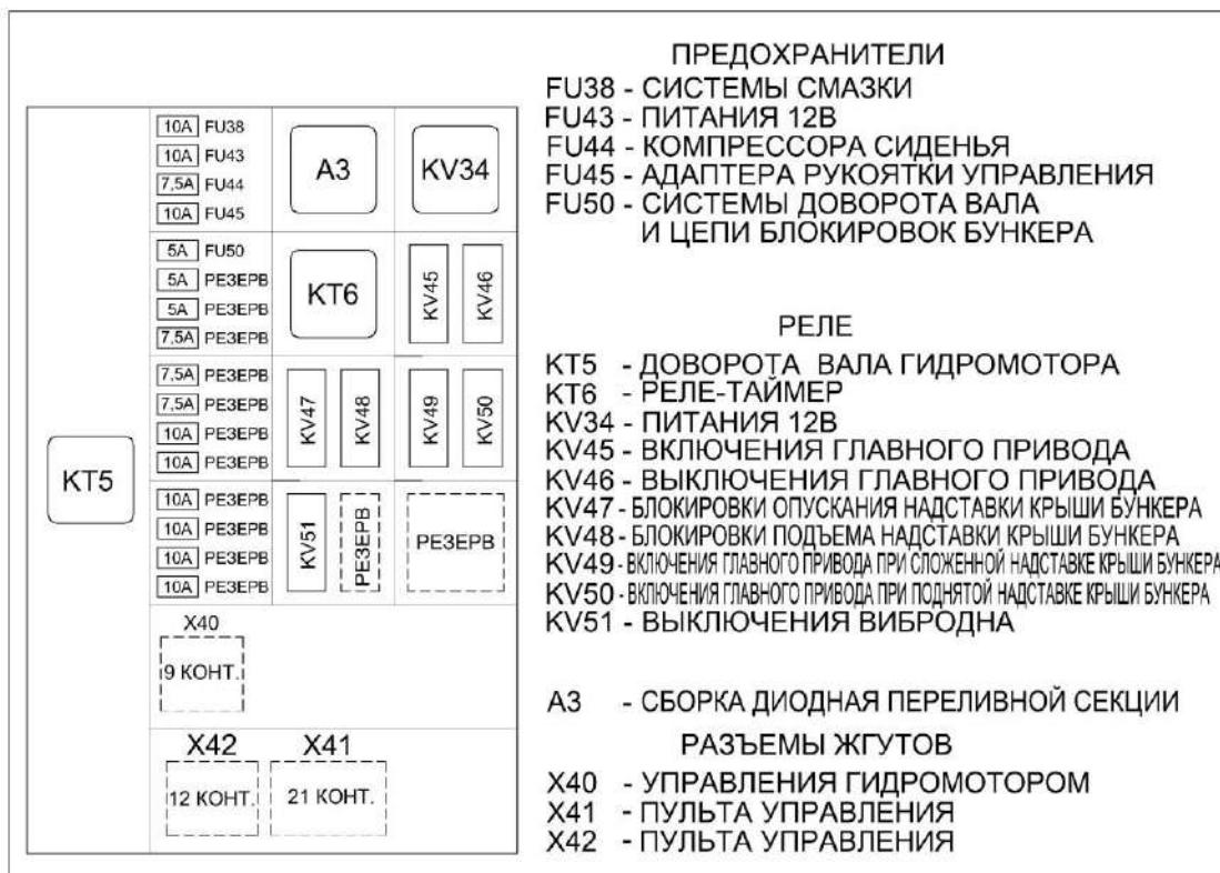
Рисунок 1.32 – Реле и предохранители пульта управления
