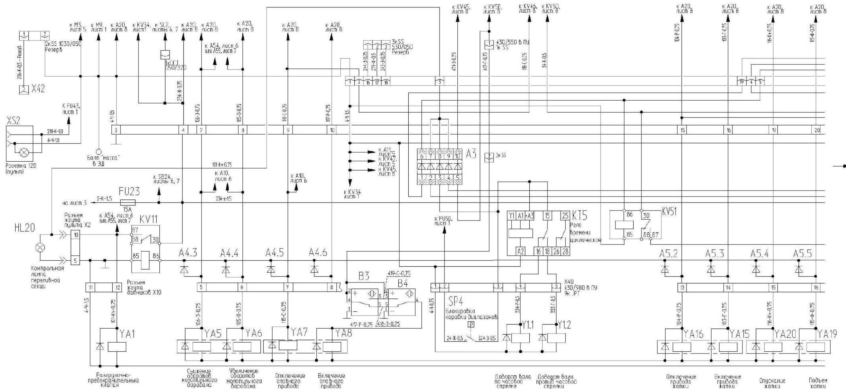
Рисунок Б.4 – Схема электрическая принципиальная комбайна (лист 4.1)
