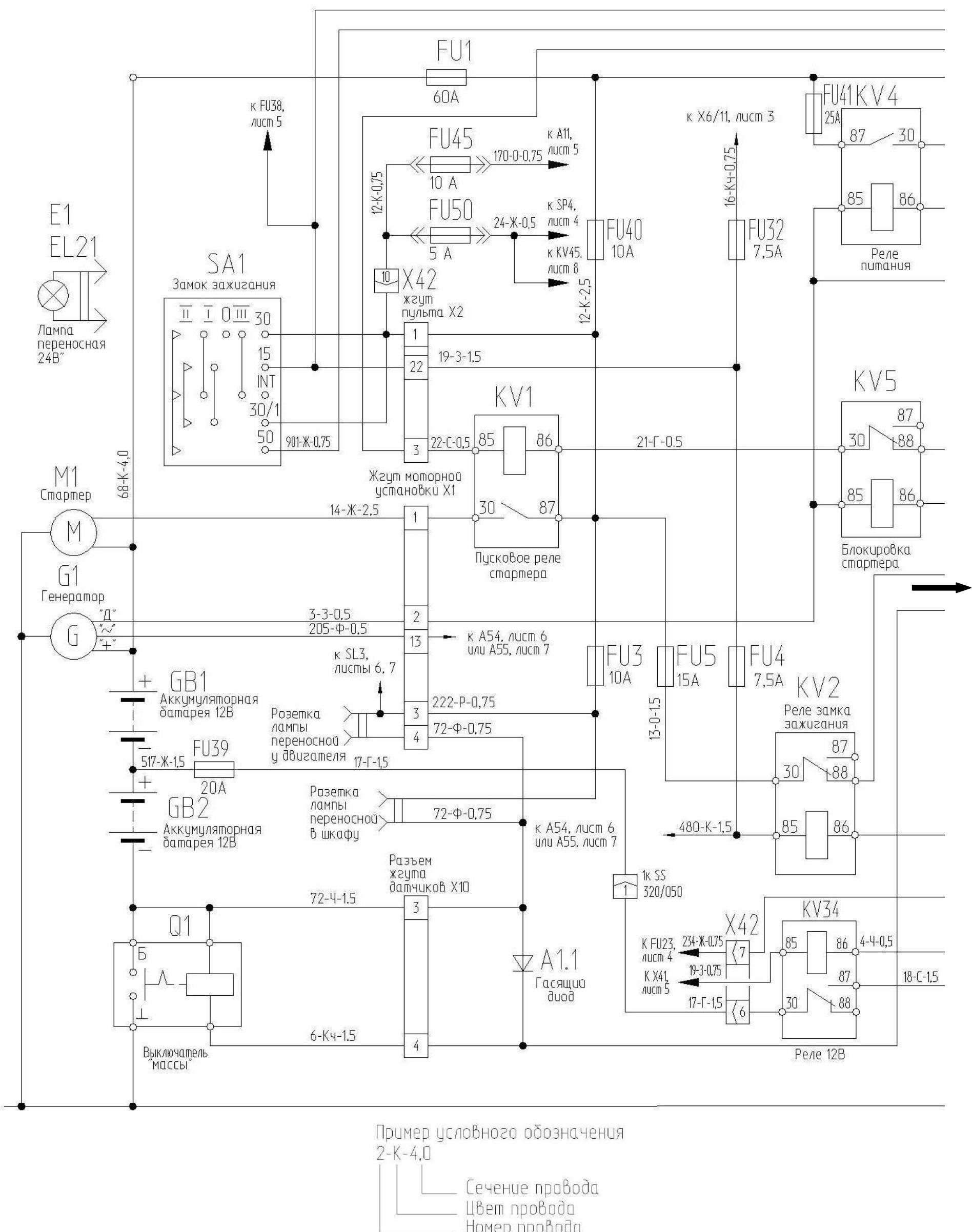
Рисунок Б.1 – Схема электрическая принципиальная комбайна (лист 1.1)
